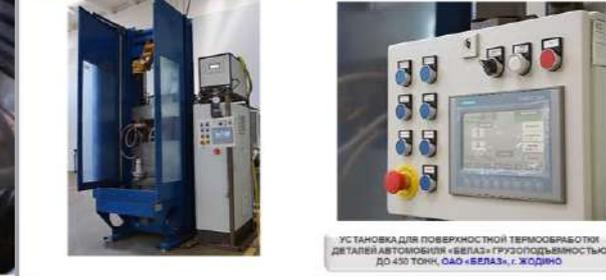
УСТАНОВКА ДЛЯ ПОВЕРХНОСТНОЙ ТЕРМООБРАБОТКИ ДЕТАЛЕЙ АВТОМОБИЛЯ «ВЕЛАЗ» ГРУЗОПОДЪЕМНОСТЬЮ ДО 430 ТОНН. ОАО «ВЕЛАЗ», г. ЖОДИНО
