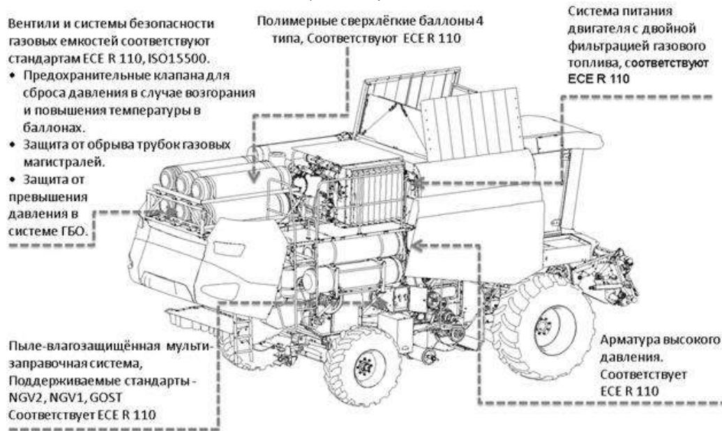
Рис. 1 – Концепция безопасности ГБО зерноуборочного комбайна GS4118K
