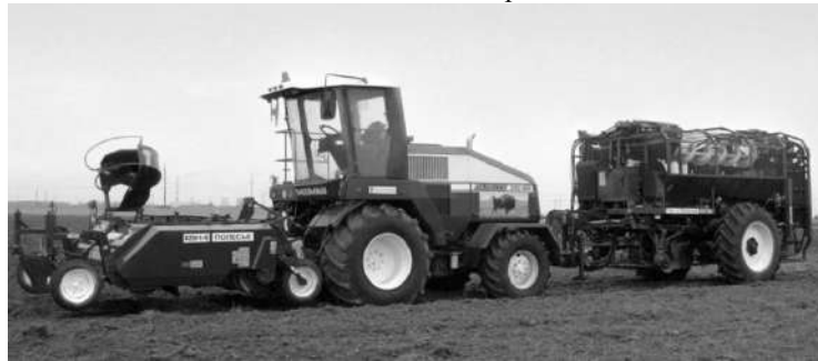
УЭС-290/450 с агрегатом АСУ-6 для однофазной уборки сахарной свеклы состоит из: навесного копателя КВН-6 на УЭС и прицепного подборщика накопителя корнеплодов ПНК-15
