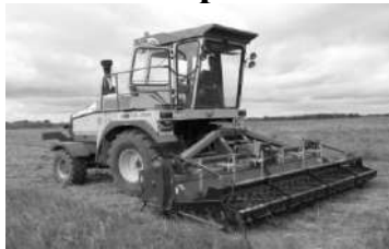
УЭС-210/280 с фрезой ФМ-3,6 на обработке задернелых почв лугов и пастбищ
