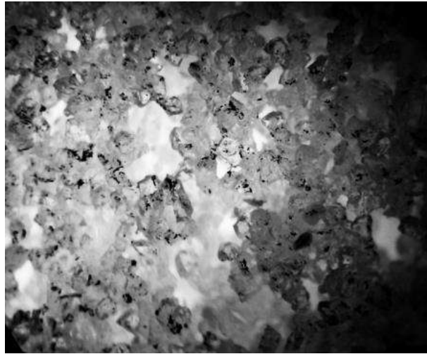
Рис. 2 - Структура шлифовального круга ЧЦ 60x48x25 25A F60
