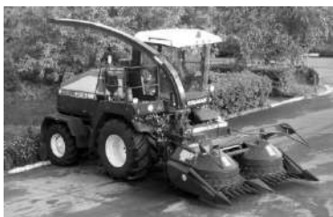
УЭС-290/450 с кормоуборочным комбайном КНК-420, предназначенным для работы с УЭС- 210/280
