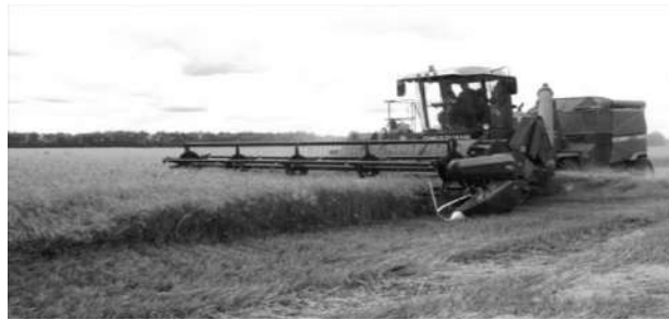
УЭС-290/450 с зерноуборочным комплексом КЗР-12 состоит из: фронтально-навесной жатки + молотильно-сепарирующего устройства на УЭС + прицепного очистителя-накопителя зерна
