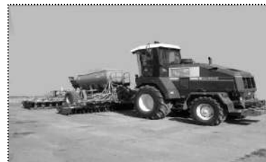
УЭС-290 с комбинированным агрегатом КА-6/8 для посева зернофуражных культур
