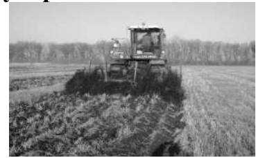
УЭС-290/450 с ротационным плугом ПРЧ-4,5 для чизельной обработки почвы и щелевания
