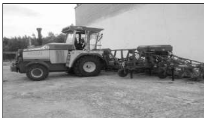
УЭС-210/280 с машиной МПТД-12 для полосного подсева трав в дернину
