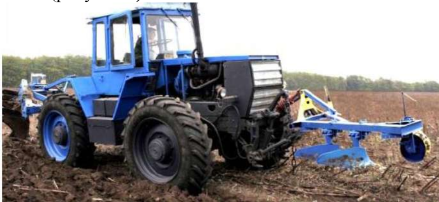
Рис.1 - Пахотный агрегат, состоящий из трактора ХТЗ-16131, передненавесного (ПЛН-2-35) и задненавесного (ПЛН-4-35) плугов
