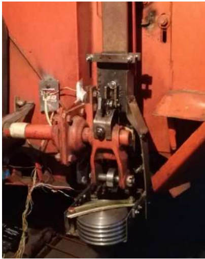
Рис. 2 - Макетный образец (а) и осциллограммы сигналов с датчиков (б) рекуперативного привода
