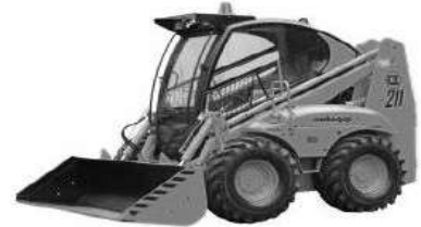
Рис. 3 – Погрузчик универсальный с бортовым поворотом АМКОДОР 211
