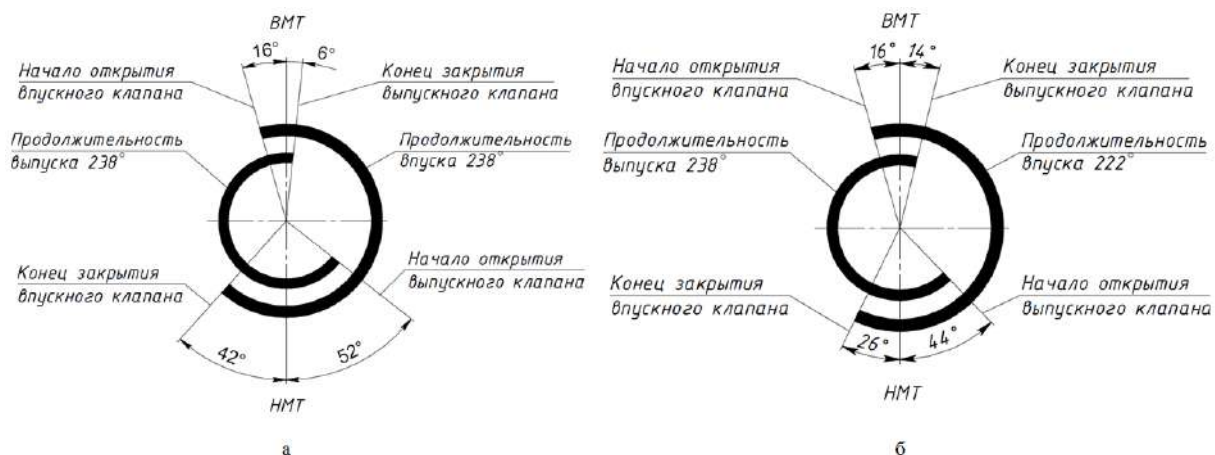
Рис. 1. Диаграммы фаз газораспределения: а - дизельного двигателя; б – газового двигателя
