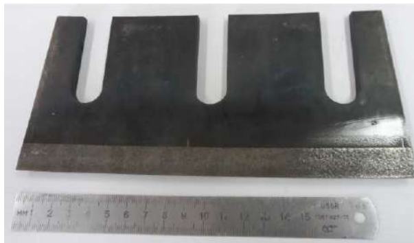
Рис. 1. Нож z81123 с напыленным покрытием
