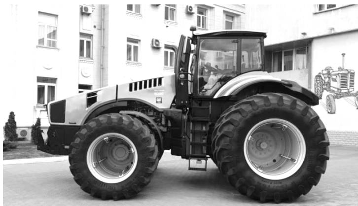
Рис. 1. Трактор BELARUS 5022 с двигателем CAT C18 Stage IIIA
