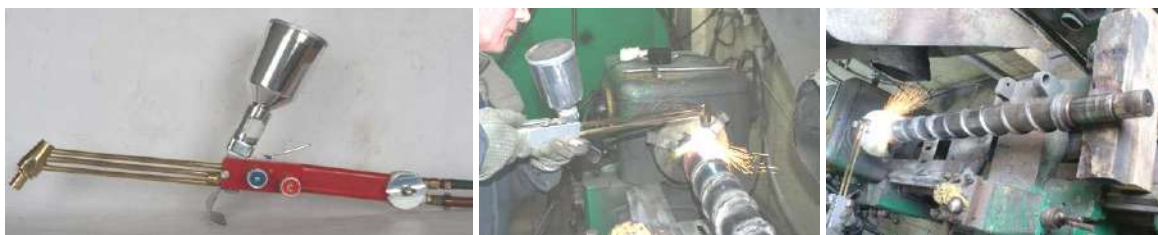
Рис. 8. Аппарат ТЕНА-ГНпм (а), процесс нанесения покрытия на шнек подающего устройства (б, в)
