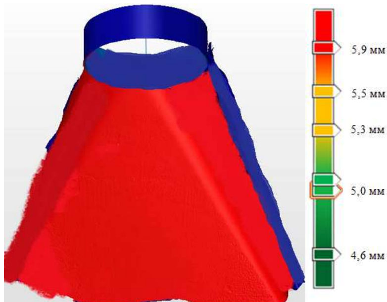
Рис.1. Виртуальная сканограмма поверхности детали КВС-1-0143425
