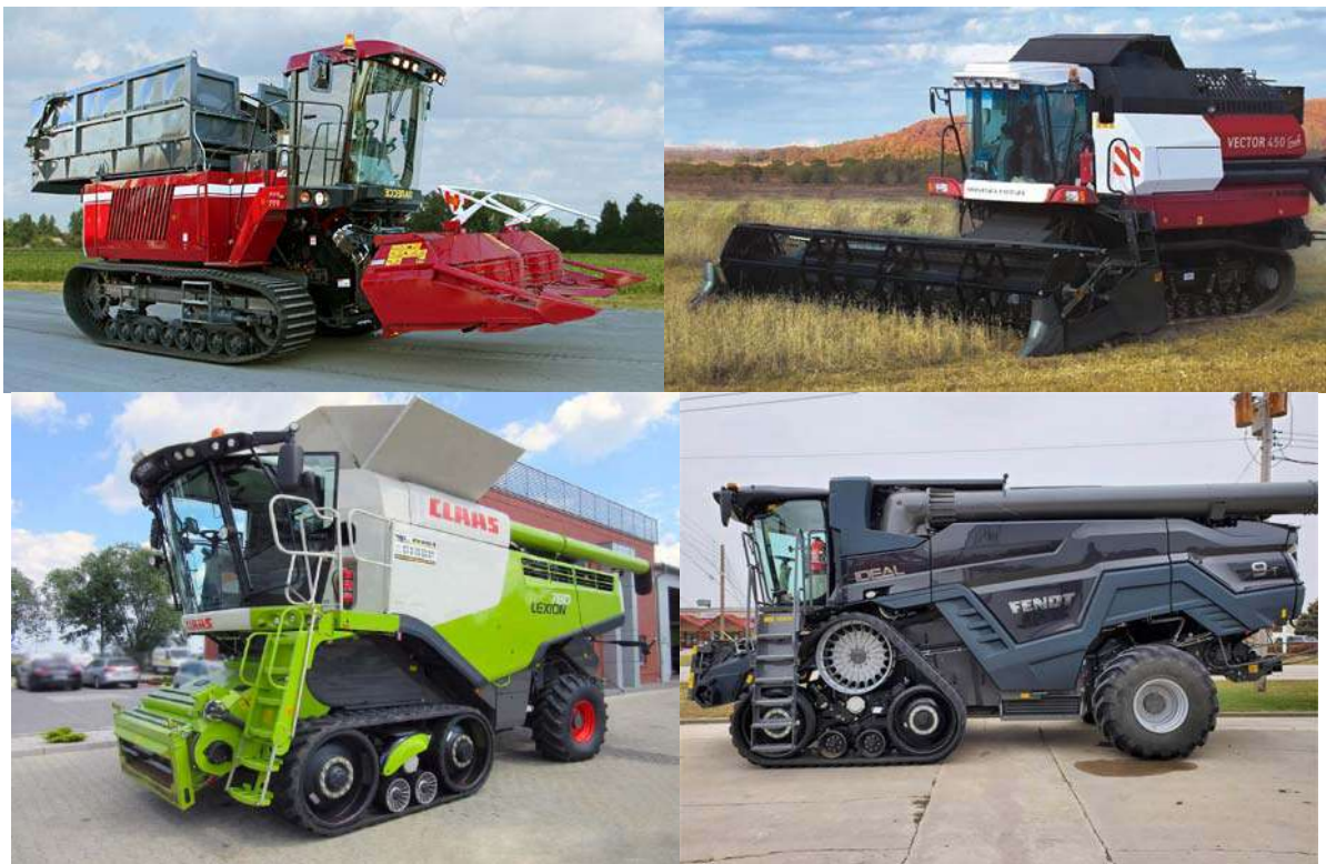
Рис. 1. Сельскохозяйственная техника на гусеничном и полугусеничном ходу с резиноармированными гусеницами
