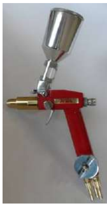
Рис. 6. Аппарат ТЕНА-Ппм с камерой сгорания 60 мм (а) и процесс напыления покрытия (б)
