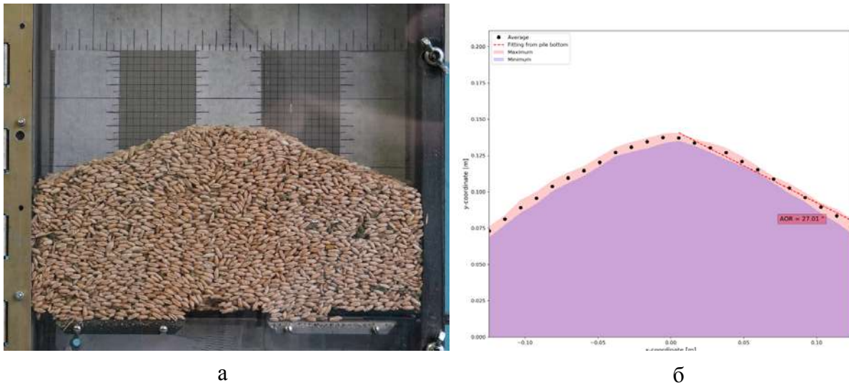
Рис. 2. Измерение угла естественного откоса сыпучего материала: а – на реальном стенде, б – на виртуальном стенде.
