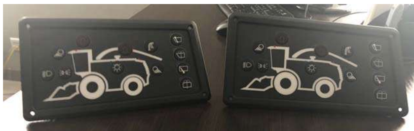
Рис.2. Панели управления освещением кормоуборочного комбайна Полесье-800А
