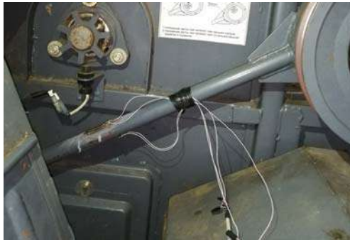
Рис. 1. Расположение датчиков на левом шатуне
