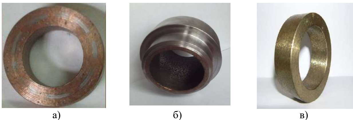
Рис. 1 - Образцы изделий из литых композиционных материалов: а) – втулка с волокнисто - гранульным армированием; б) – биметаллическая втулка элемента подвески прицепа; в) – композиционная втулка механизма дверей
