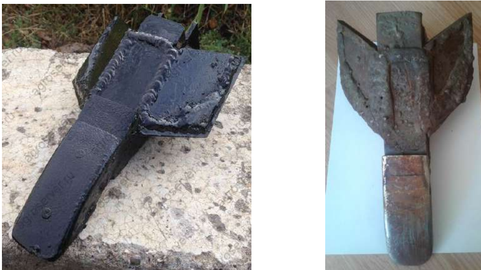
Рис.1 – Новая и восстановленная лапа глубокорыхлителя Case IH ECOLO-Tiger 730C
