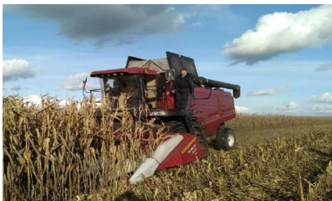
Рис. 17 – Работа зерноуборочного комбайна GS12A1 в режиме беспилотного вождения.
