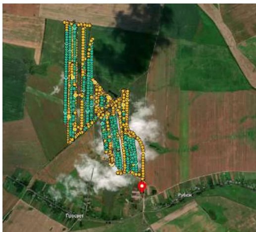
Рис. 16 – Траектория движения комбайна по данным телеметрии, с указанием участков движения комбайна под управлением системы Cognitive Agro Pilot.
