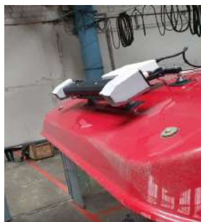
Рис. 3 – Интегрированный модуль сенсоров, установленный на крыше кабины зерноуборочного комбайна
