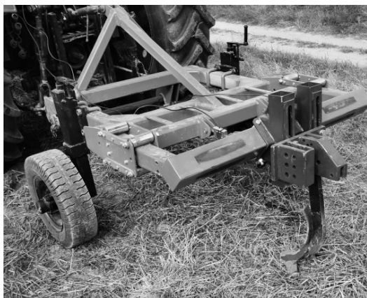
Рис. 1–Исследование тягового сопротивления рабочего органа для культивации (стрельчатая лапа на жесткой стойке)
