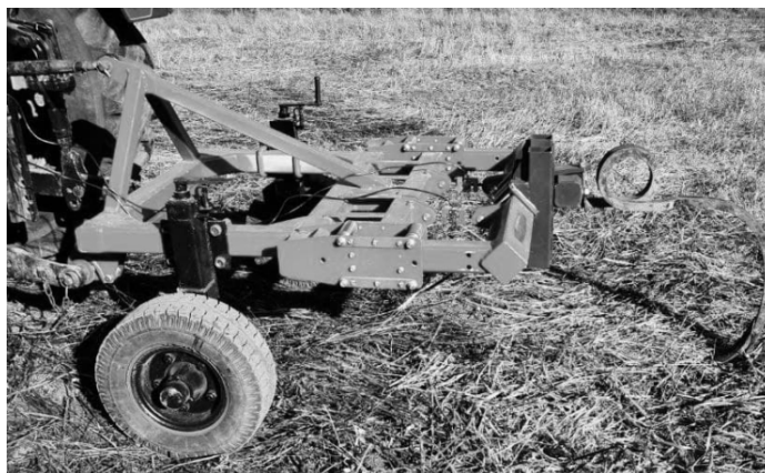
Рис. 2–Исследование тягового сопротивления рабочего органа для культивации (долотообразная лапа на пружинной стойке)
