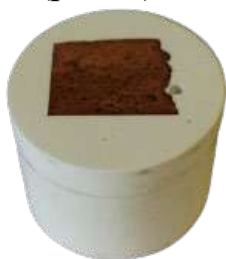
Рис. 2 – Запрессованный образец Рис. 3 – Схема холодной запрессовки
