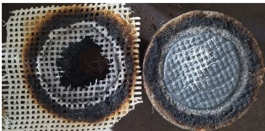
Рис. 3 - Камера фильтрации с прогоревшей сеткой типа ССФ
