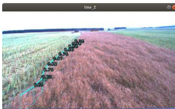
Рис. 7 – Отображение положения проекции кромки стеблестоя после обработки алгоритмами программы в синхронном стереорежиме
