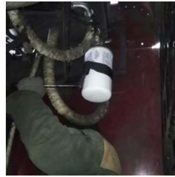
Рисунок 3.9 – Сливной фильтроэлемент, демонтируемый при помощи ключа фильтра
