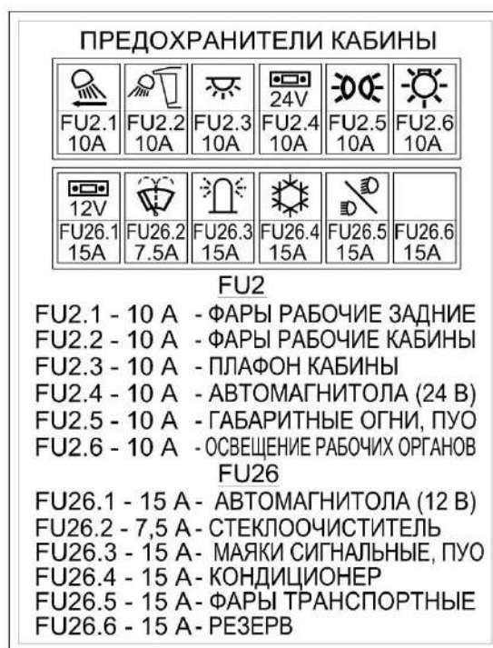
Рисунок 1.40 – Схема расположения предохранителей
