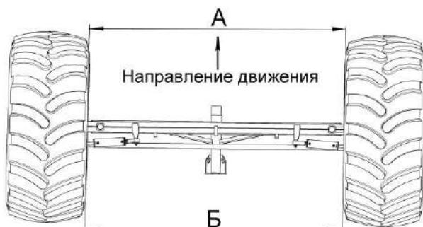
Рисунок 2.14 – Регулировка сходимости колес
