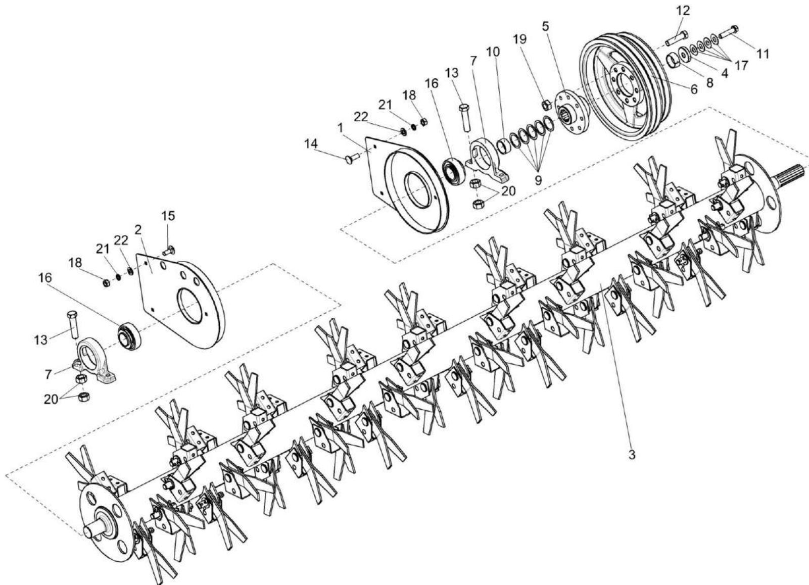
Рисунок 37 – Привод устройства бильного (правой секции) (изображено)
