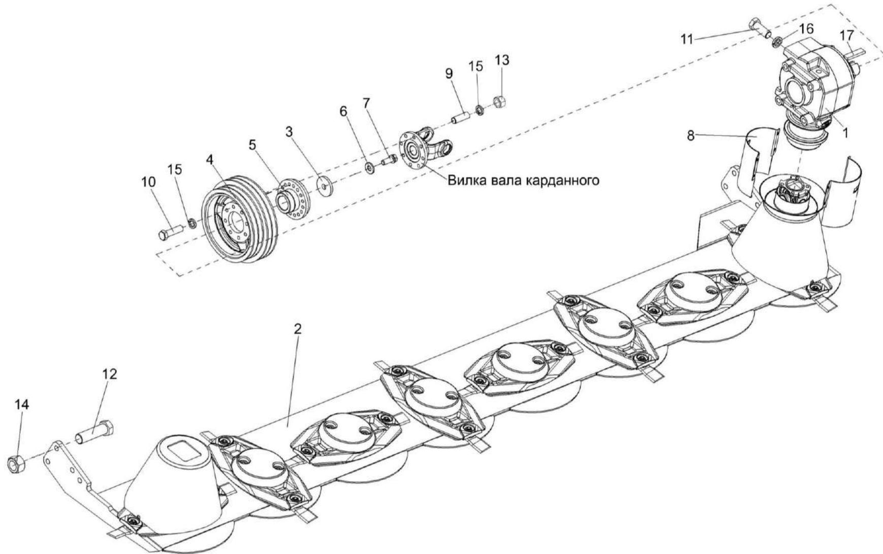
Рисунок 41 – Привод режущего аппарата (правой секции) (изображено)
