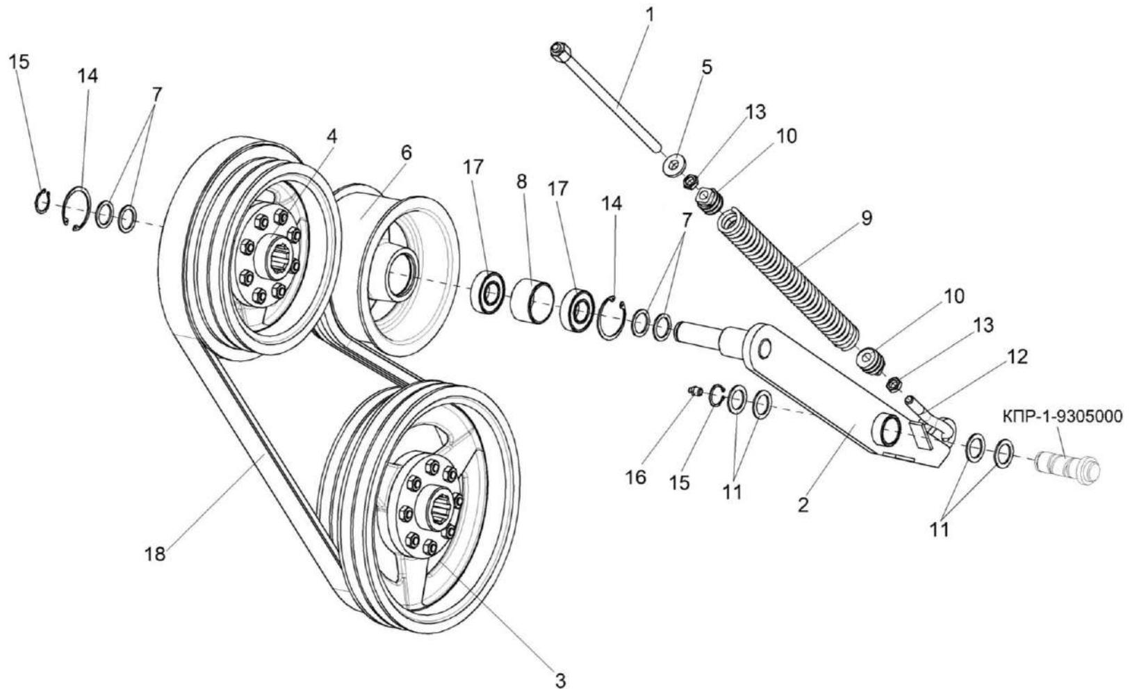
Рисунок 18 – Устройство натяжное центральной секции КПР 9206000А-01
