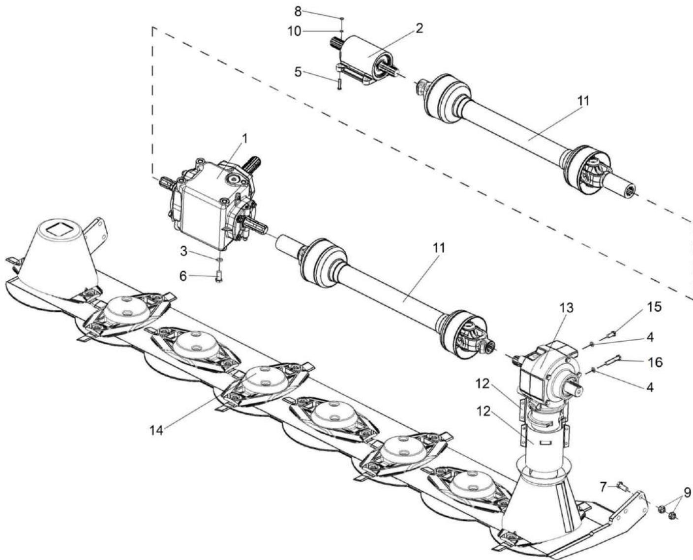
Рисунок 12– Привод режущего аппарата центральной секции
