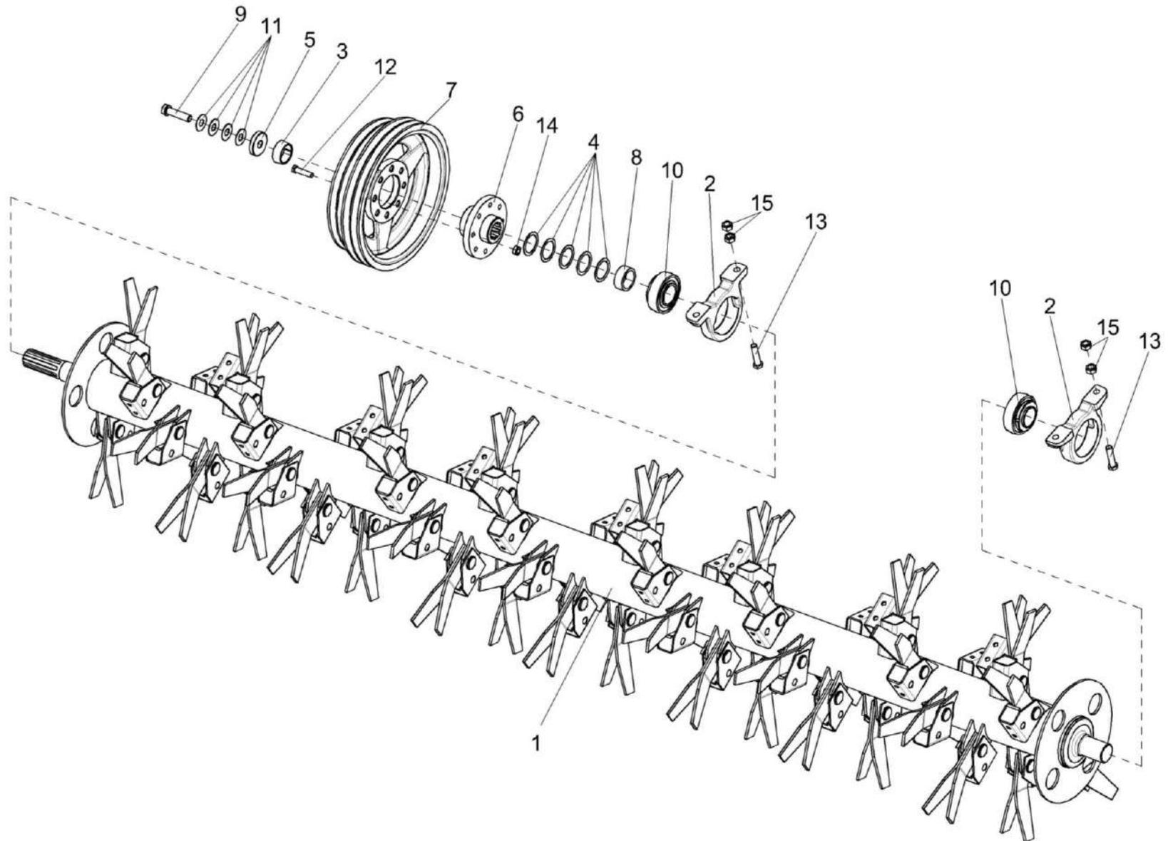
Рисунок 15 – Установка бильного устройства центральной секции
