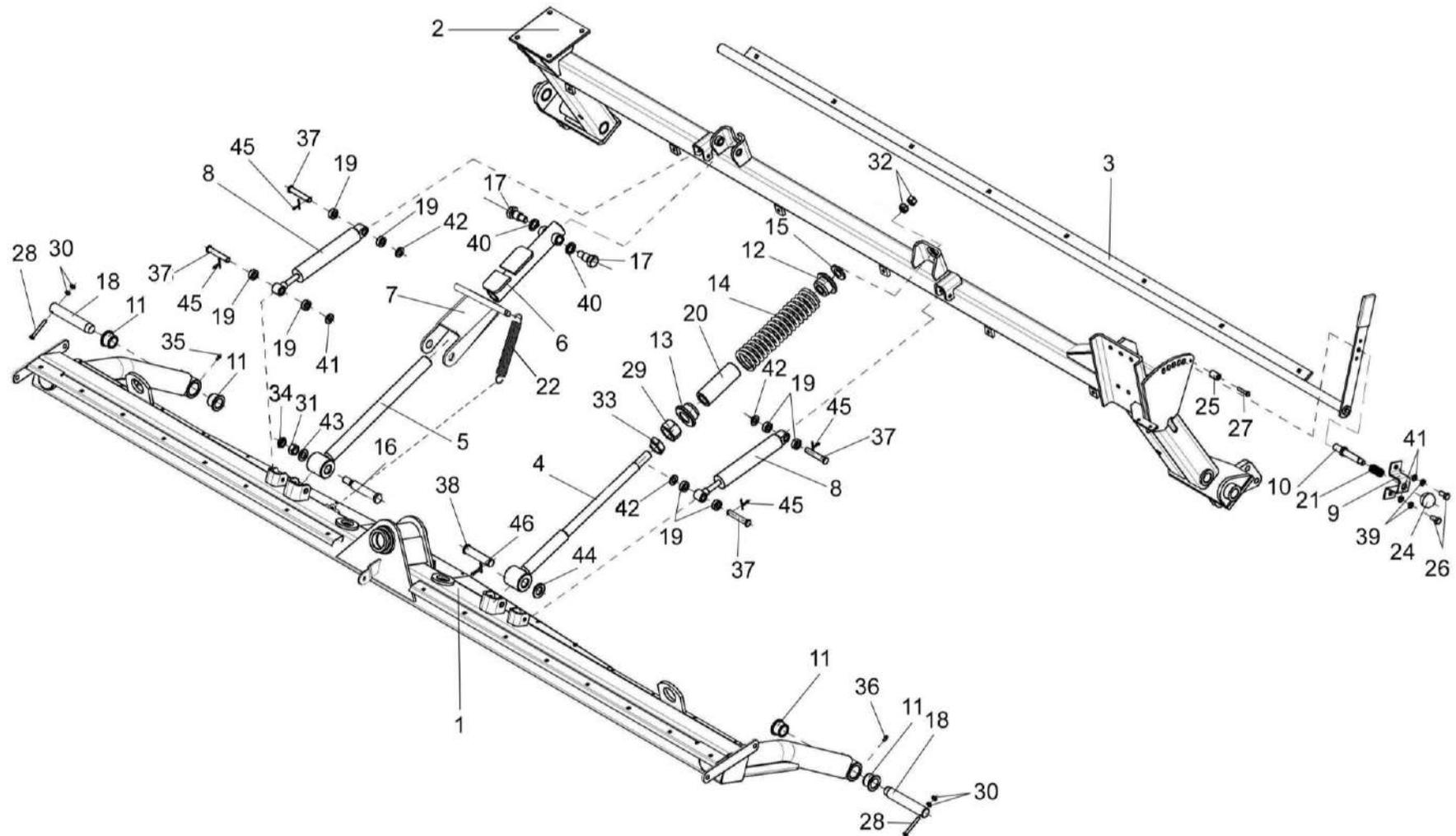
Рисунок 9 – Установка коромысла КПР-1-9304000 и рамы КПР-1-9308000
