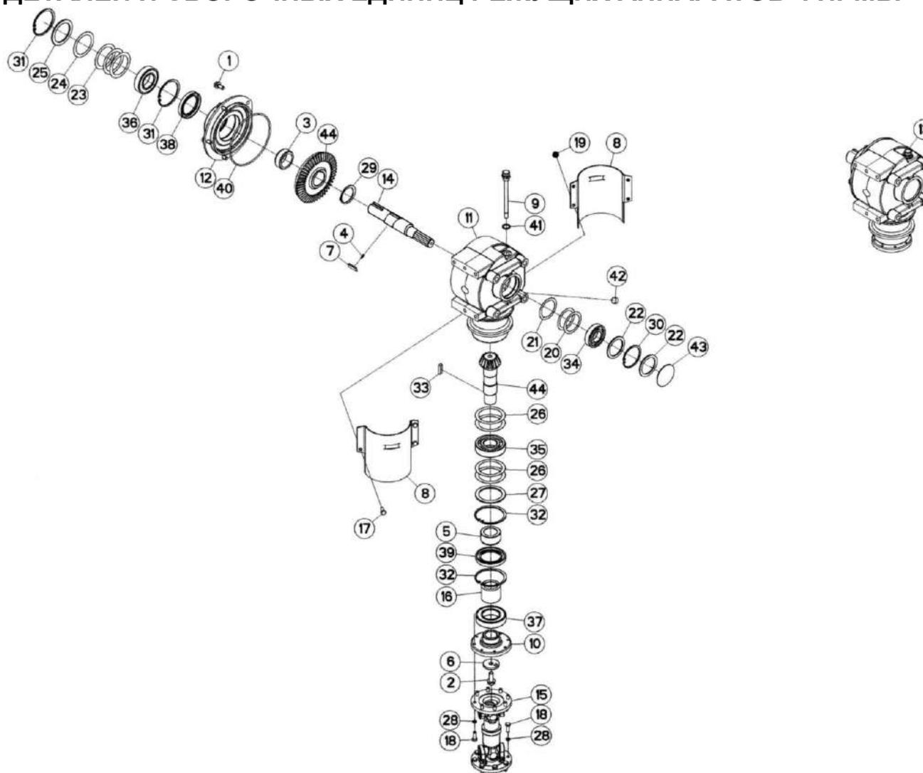
Рисунок А.1 – Редуктор центральной секции
