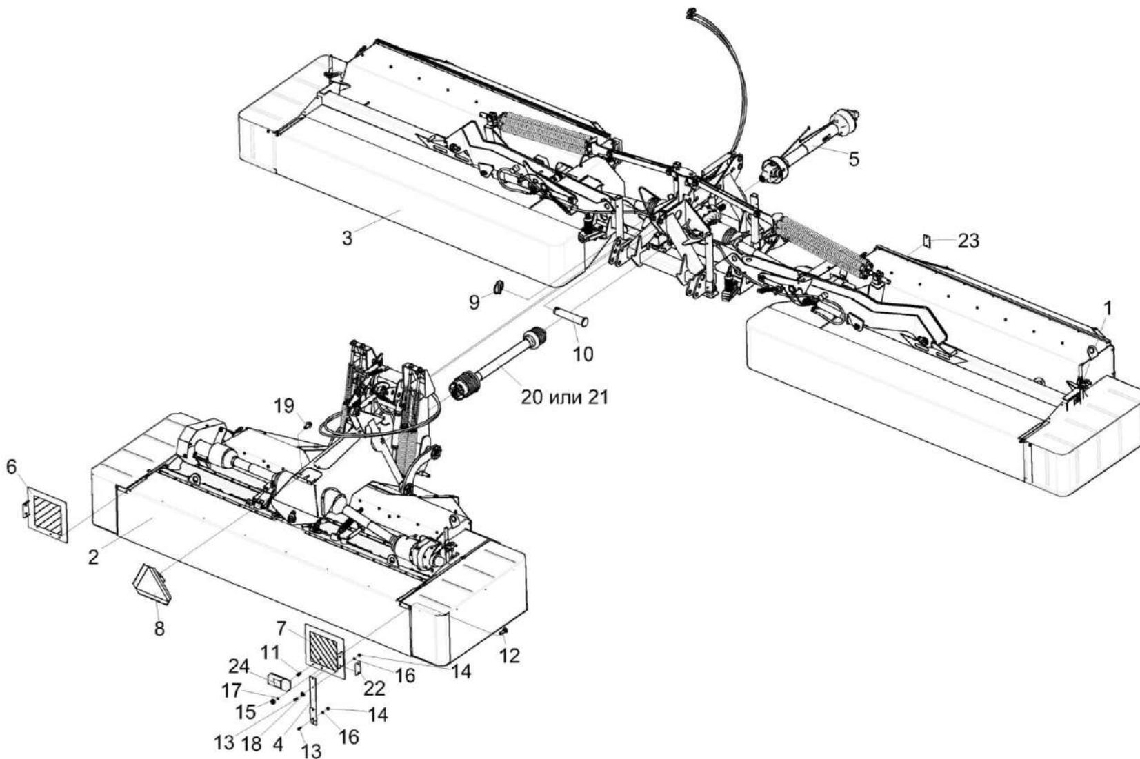
Рисунок 1 – Косилка-плющилка ротационная навесная трехсекционная КПР 9 КПР 9000000-05
