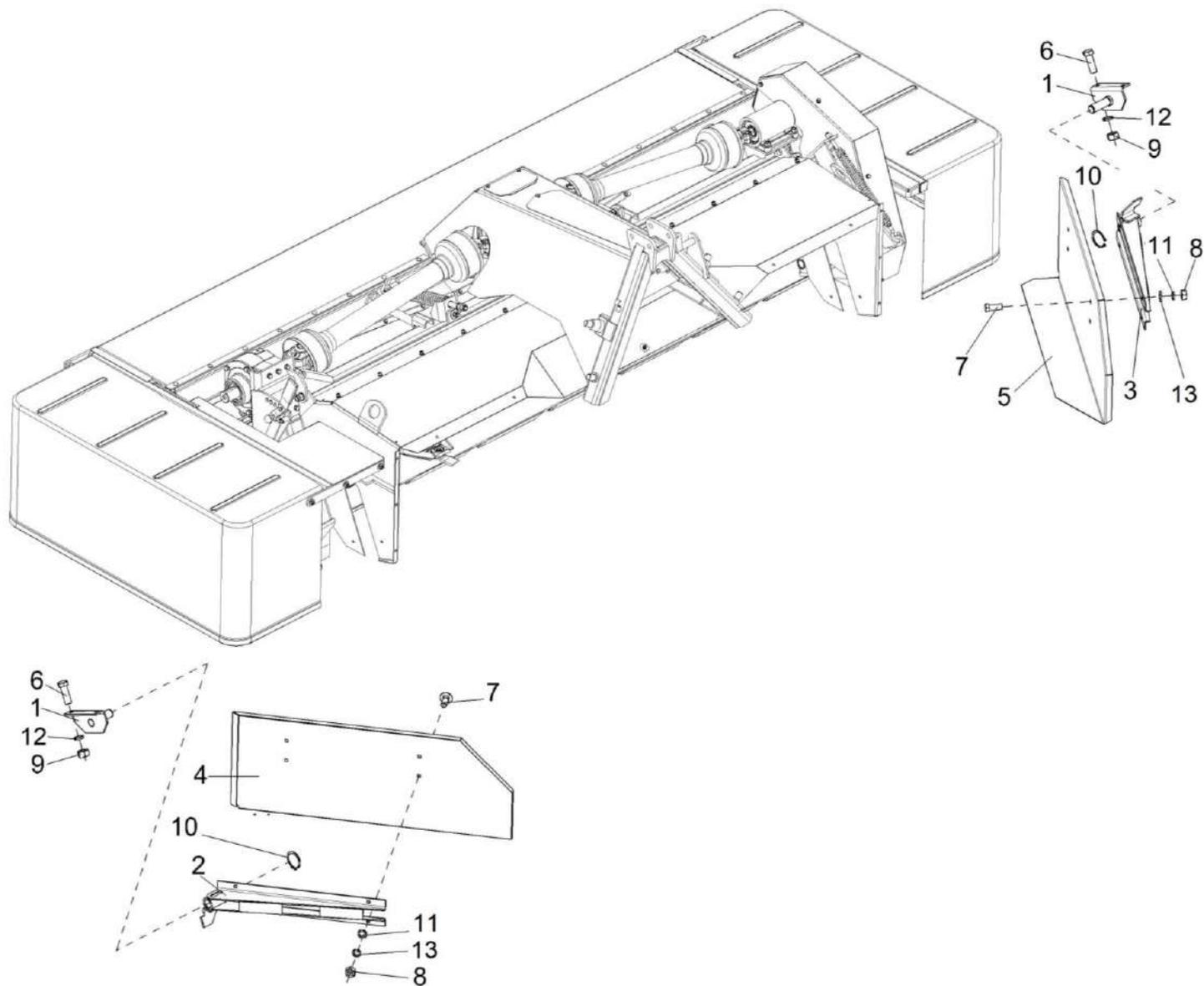
Рисунок 50 – Установка сменных щитков (секция центральная)
