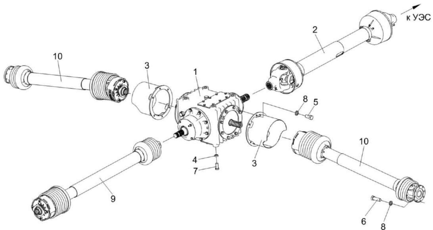
Рисунок 24 – Установка редуктора КПР 9103100
