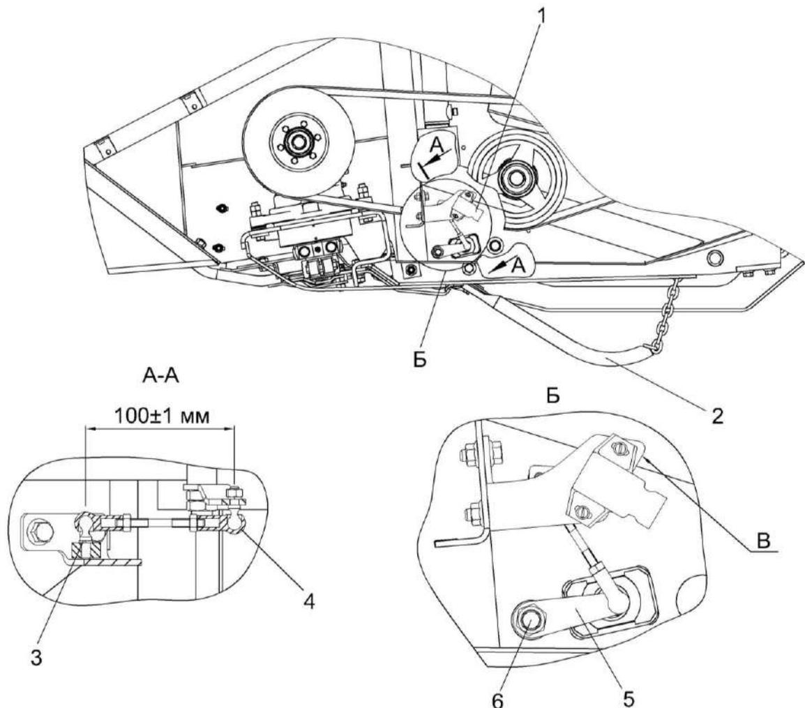
1- датчик положения копиров; 2 – копир; 3, 4 – шарниры; 5 - рычаг; 6 - гайка
