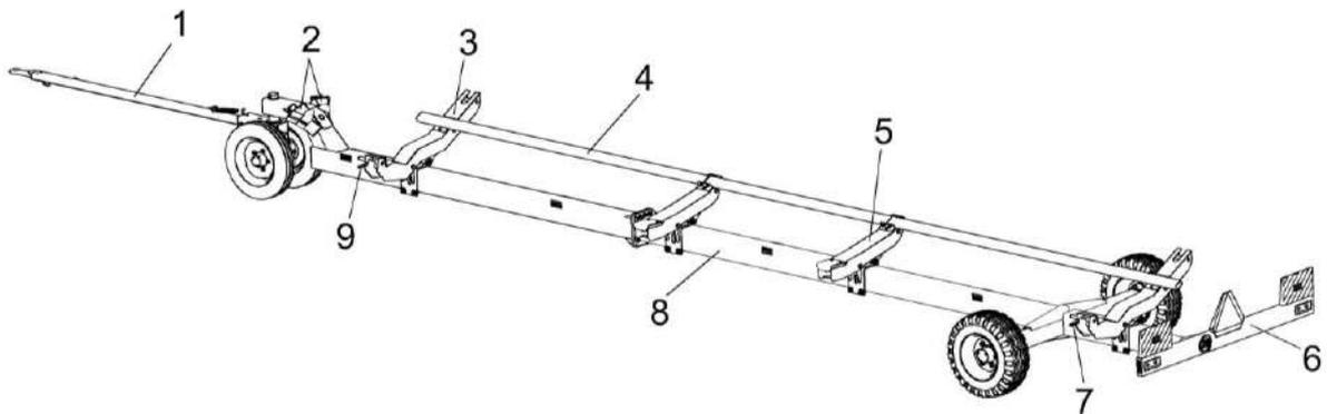
1 – дышло; 2 - упоры противооткатные; 3, 5 - ложементы; 4 – упоры; 6 – балка габаритная; 8 – рама тележки; 7, 9 – фиксаторы
