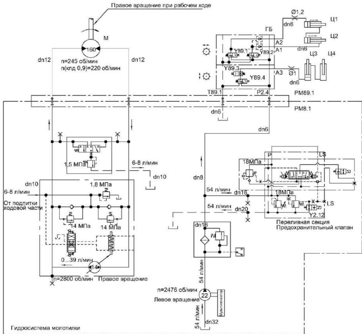
Ц1, Ц2 - гидроцилиндры горизонтального перемещения мотовила; Ц3, Ц4 - гидроцилиндры вертикального перемещения мотовила; М - гидромотор привода мотовила; ГБ – гидроблок; РМ8.1 – разъем мобильный; РМ89.1 – разъем стационарный
