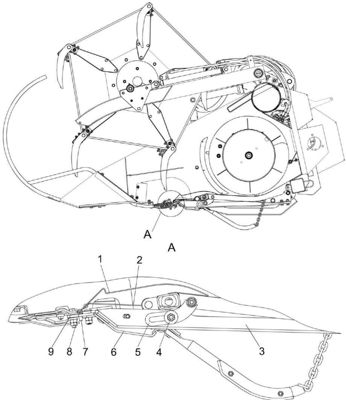
1 - щиток; 2 – рессора; 3 - рычаг; 4 – гайка; 5 – ограничитель хода; 6 - ползья; 7 – винт;
