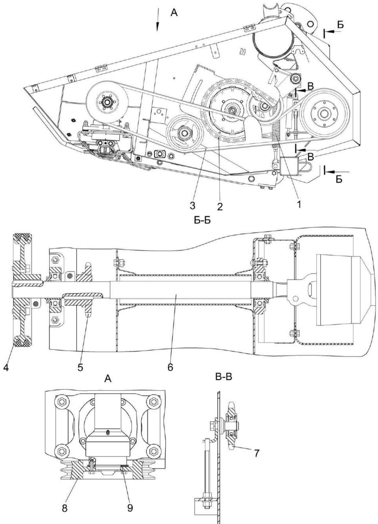
1 - пружина; 2 – цепная передача; 3 - ременная передача; 4, 8 - звездочки; 5, 7 - шкивы; 6 – вал; 9 - прокладки
