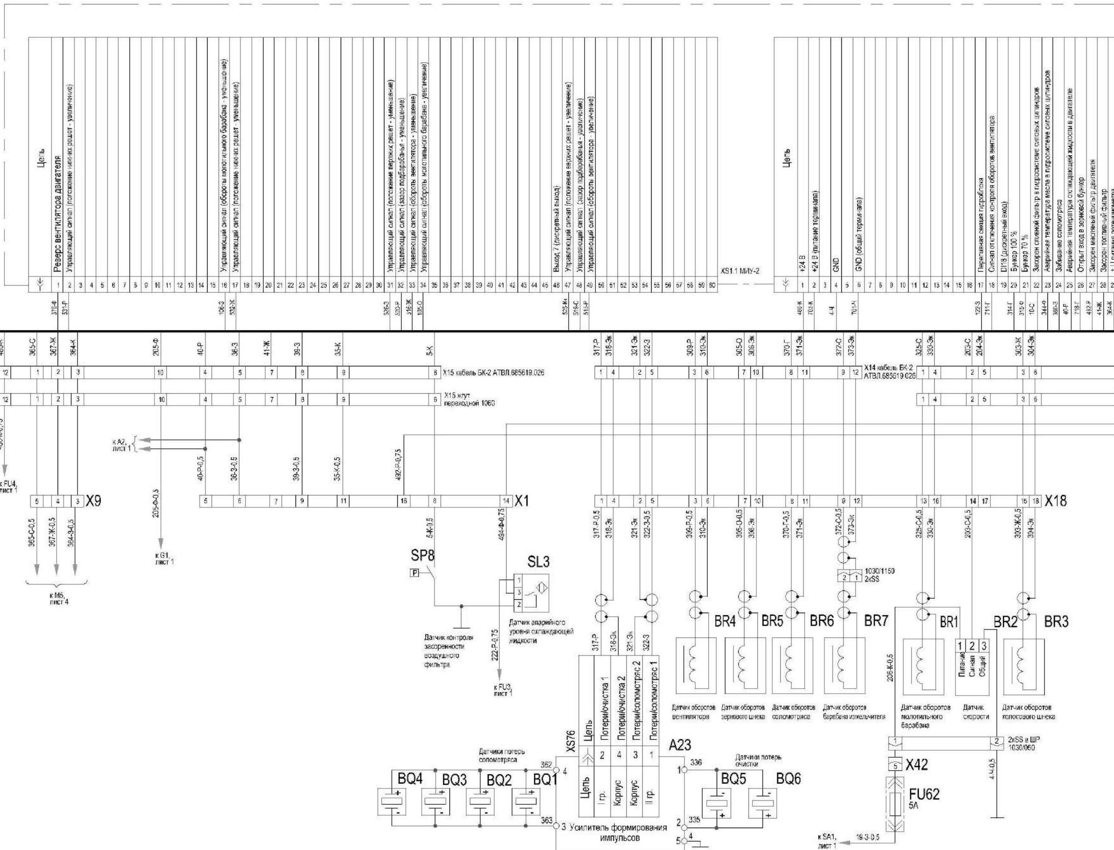
Рисунок Б.6 – Схема электрическая принципиальная комбайна (лист 6.1)
