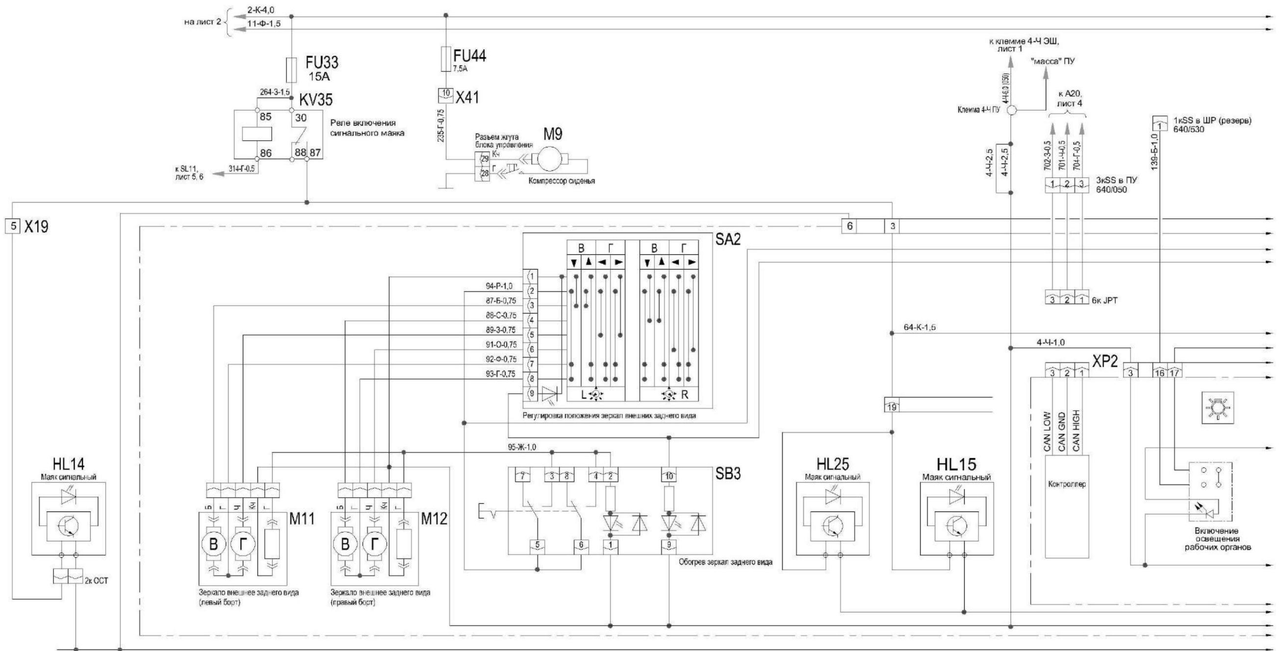
Рисунок Б.3 – Схема электрическая принципиальная комбайна (лист 3.1)
