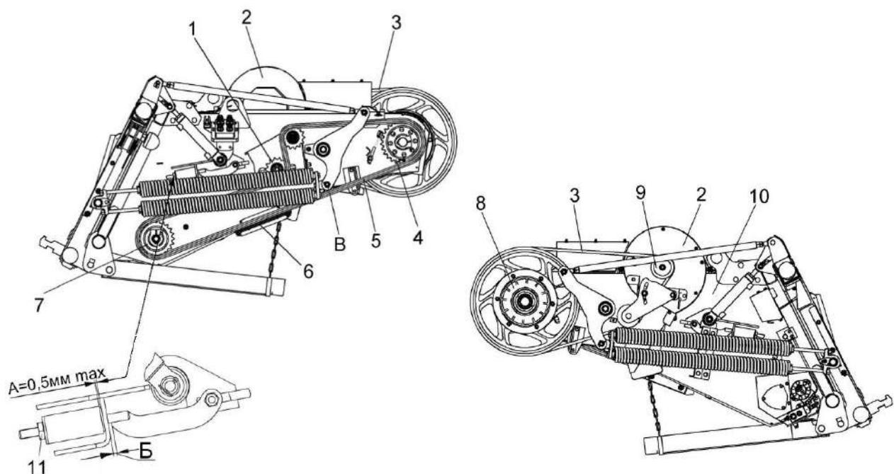
1, 4, 7 – звездочки; 2 – вентилятор; 3 – ременная передача; 5 – цепная передача; 6 – успокоитель; 8 – муфта предохранительная; 9 – ролик натяжной; 10 – рама; 11 – гайка
