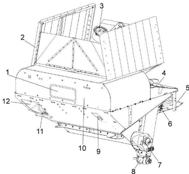
1 – смотровое окно; 2 – крыша бункера; 3 – шнек загрузной зерновой; 4 – шнек наклонный выгрузной; 5 – настил; 6 – виброродно; 7 – шнек горизонтальный; 8 – редуктор; 9 – окно пробоотборника; 10 – бункер; 11 – поручень; 12 – крышка
