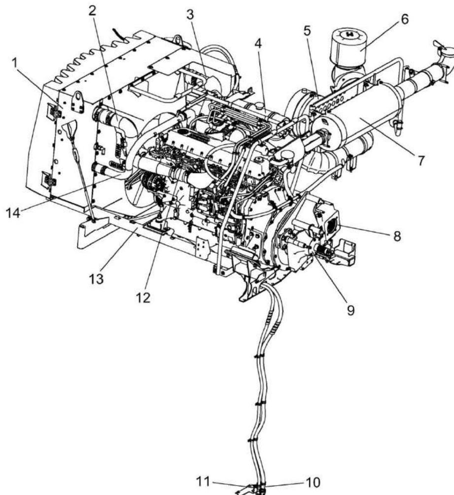
1 – радиатор; 2, 3 – трубы воздушные; 4 – бак расширительный; 5 – фильтр воздушный; 6 – воздухозаборник вращающийся; 7 – глушитель; 8 – установка гидронасосов; 9 – главный привод; 10 – сливной рукав масла из редуктора и картера двигателя; 11 – сливной рукав охлаждающей жидкости; 12 – двигатель; 13 – рама подмоторная; 14 – труба водяная верхняя
