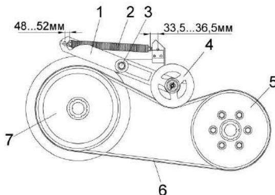
1 – рычаги; 2 – пружина; 3 – ось; 4 – ролик натяжной; 5, 7 – шкивы; 6 – ремень
