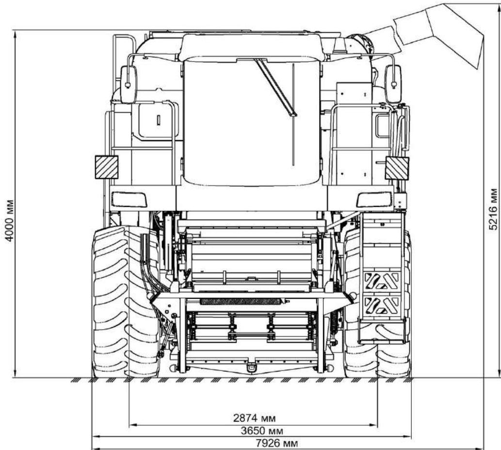
Рисунок 1.1 – Габаритные размеры комбайна
