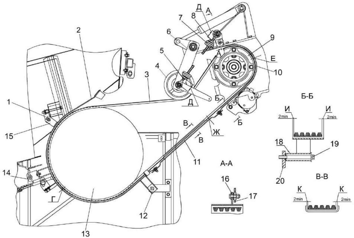
1, 12, 14, 15, 16, 17, 20 – кронштейны; 2, 10, 11 – щитки; 3 – ремень; 4 – ролик; 5, 8 – гайки;
