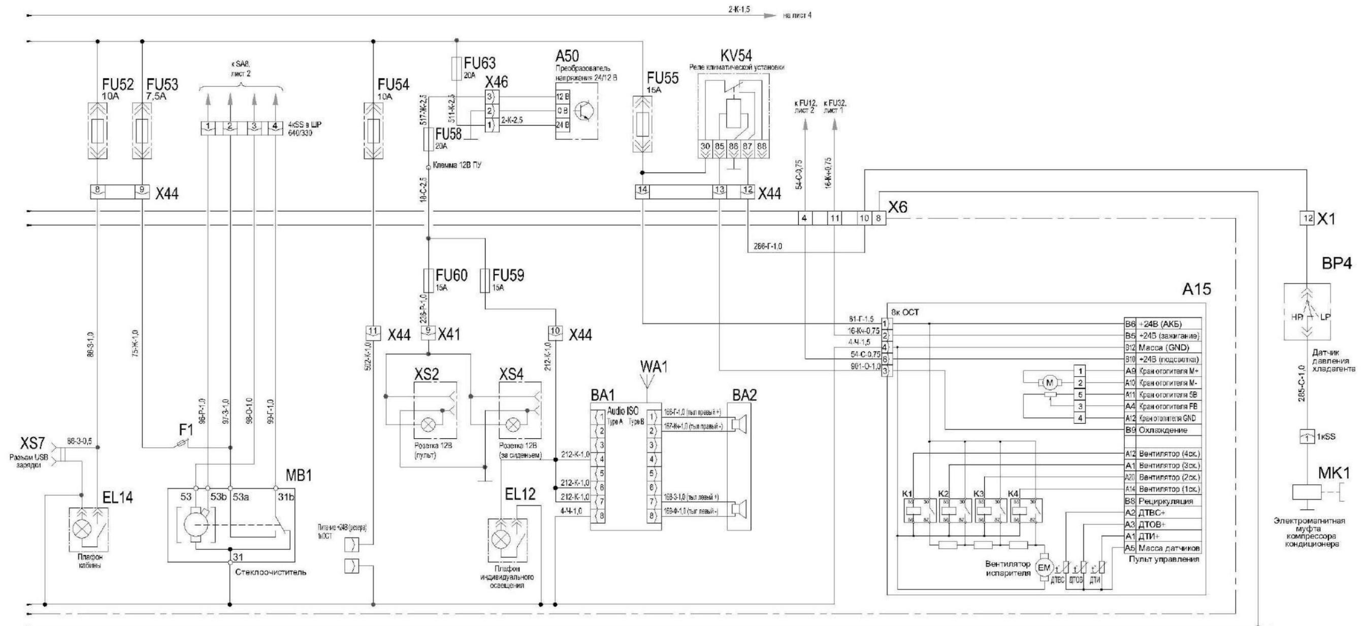
Рисунок Б.3 – Схема электрическая принципиальная комбайна (лист 3.3)
