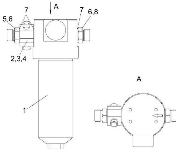
1 – фильтр напорный ФСК-20-МА; 2 – угольник поворотный; 3, 4, 6 – заглушки; 5 – болт поворотного угольника; 7 – прокладки; 8 – штуцер
