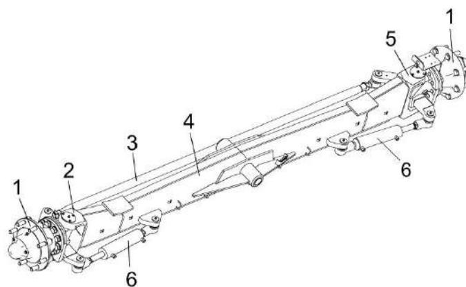
1 – ступица; 2, 5 – поворотный кулак; 3 – тяга рулевая; 4 – балка; 6 – гидроцилиндр
