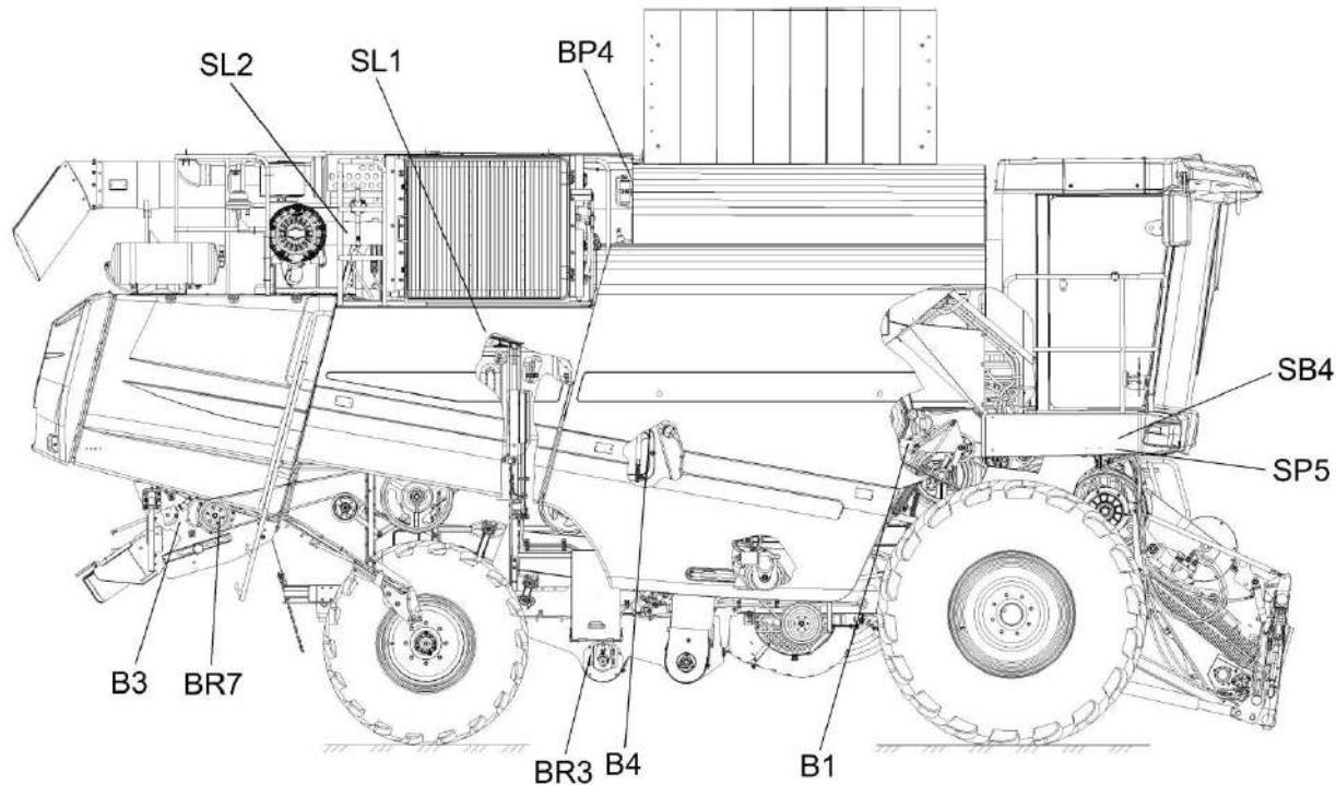
Рисунок 1.29 – Расположение датчиков на комбайне (вид справа)
