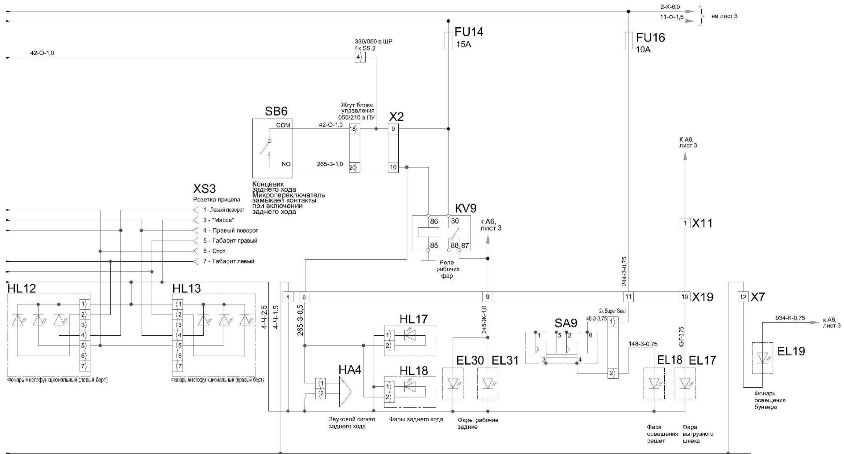
Рисунок Б.2 – Схема электрическая принципиальная комбайна (лист 2.3)
