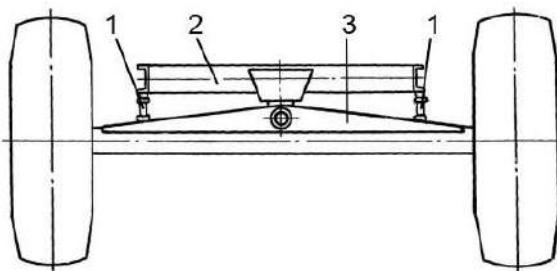
1 – болты; 2 – труба рамы; 3 – балка моста управляемых колес
