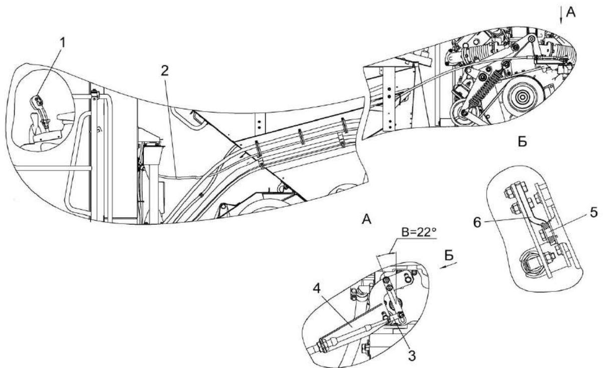
1 – рукоятка управления скоростью движения; 2 – трос; 3 – ось; 4 – кронштейн; 5 – вал управления; 6 – флажок гидронасоса
