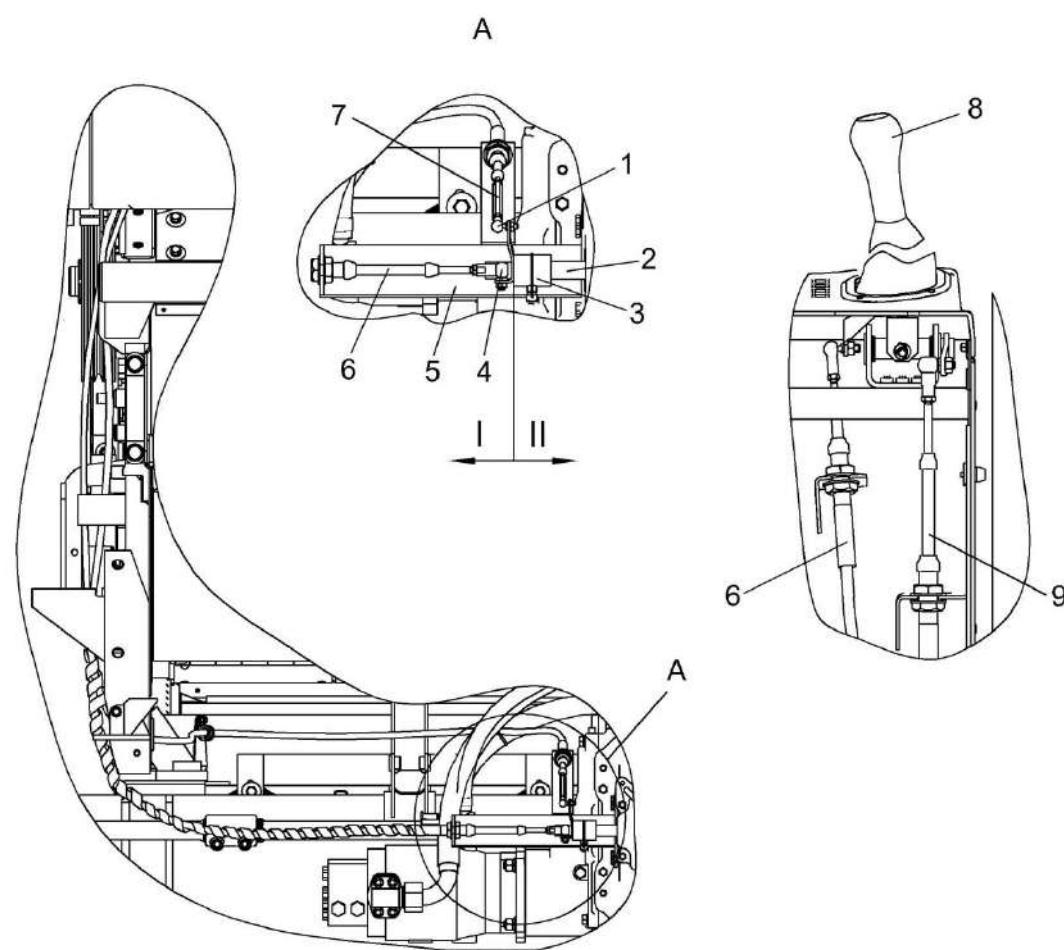
1, 4 – шарниры угловые; 2 – шток коробки диапазонов; 3 – поводок; 5 – кронштейн; 6, 9 – штоки тросов; 7 – тяга; 8 - рычаг
