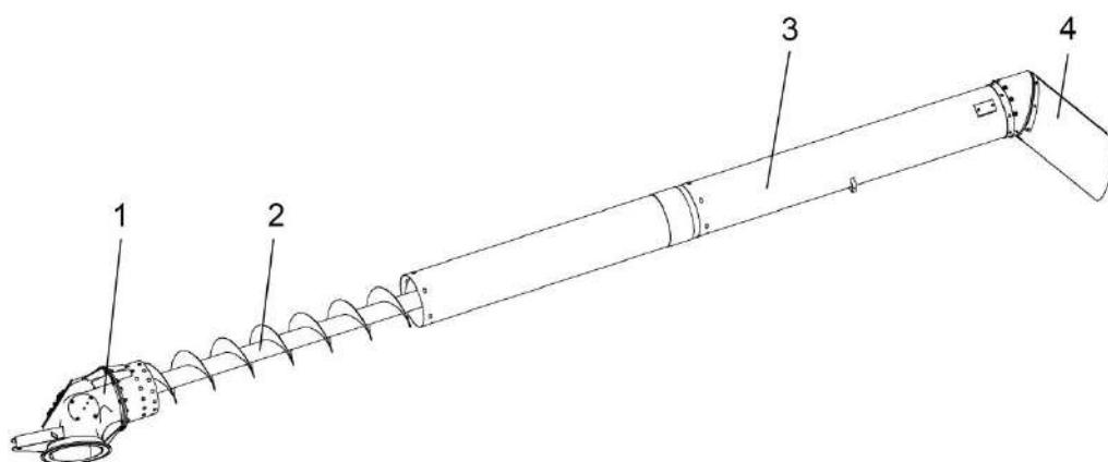
1 – отвод с редуктором; 2 – шнек; 3 – кожух; 4 – фартук
