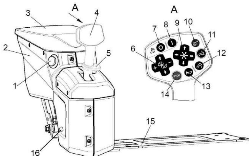
1 – кнопка; 2 – блок управления; 3 – подлокотник; 4 – рукоятка управления скоростью движения; 5 – упор; 15 – кронштейн; 16 – болт
