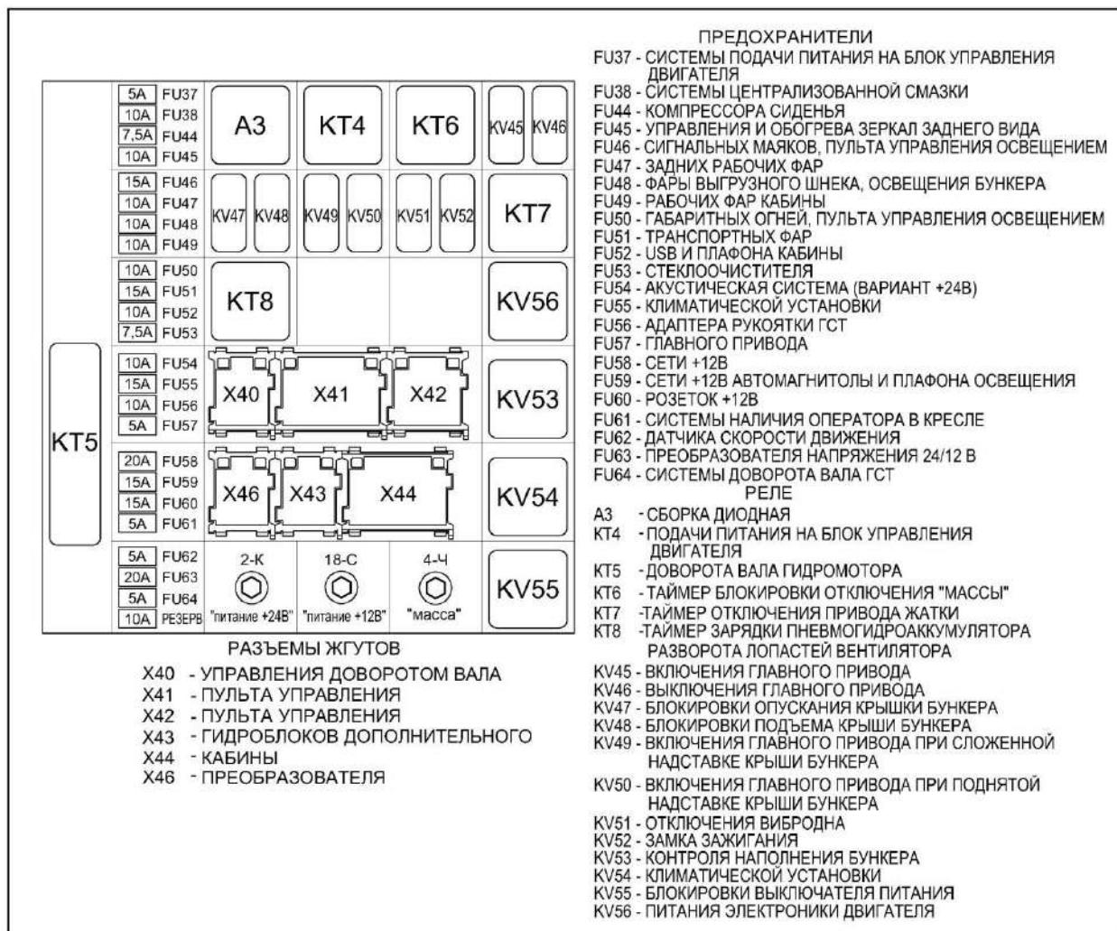
Рисунок 1.38 – Реле и предохранители пульта управления
