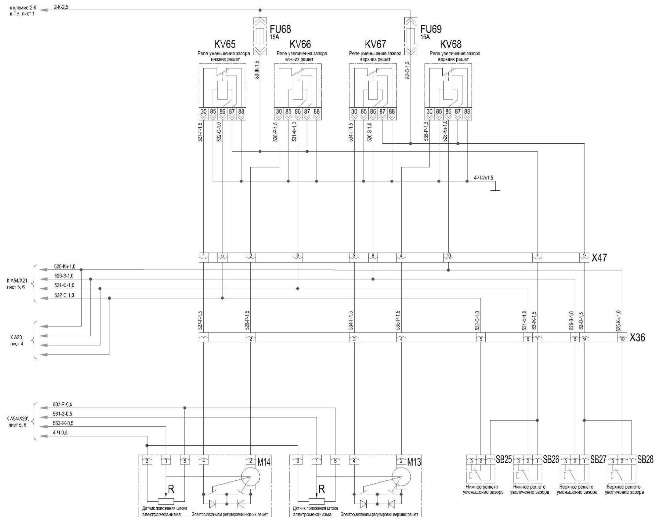
Рисунок Б.7 – Схема электрическая принципиальная комбайна (лист 7)
