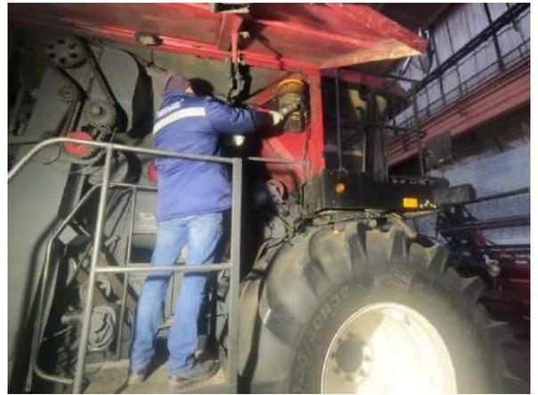
Рисунок 3.4 – Заправка насоса АЦСС
