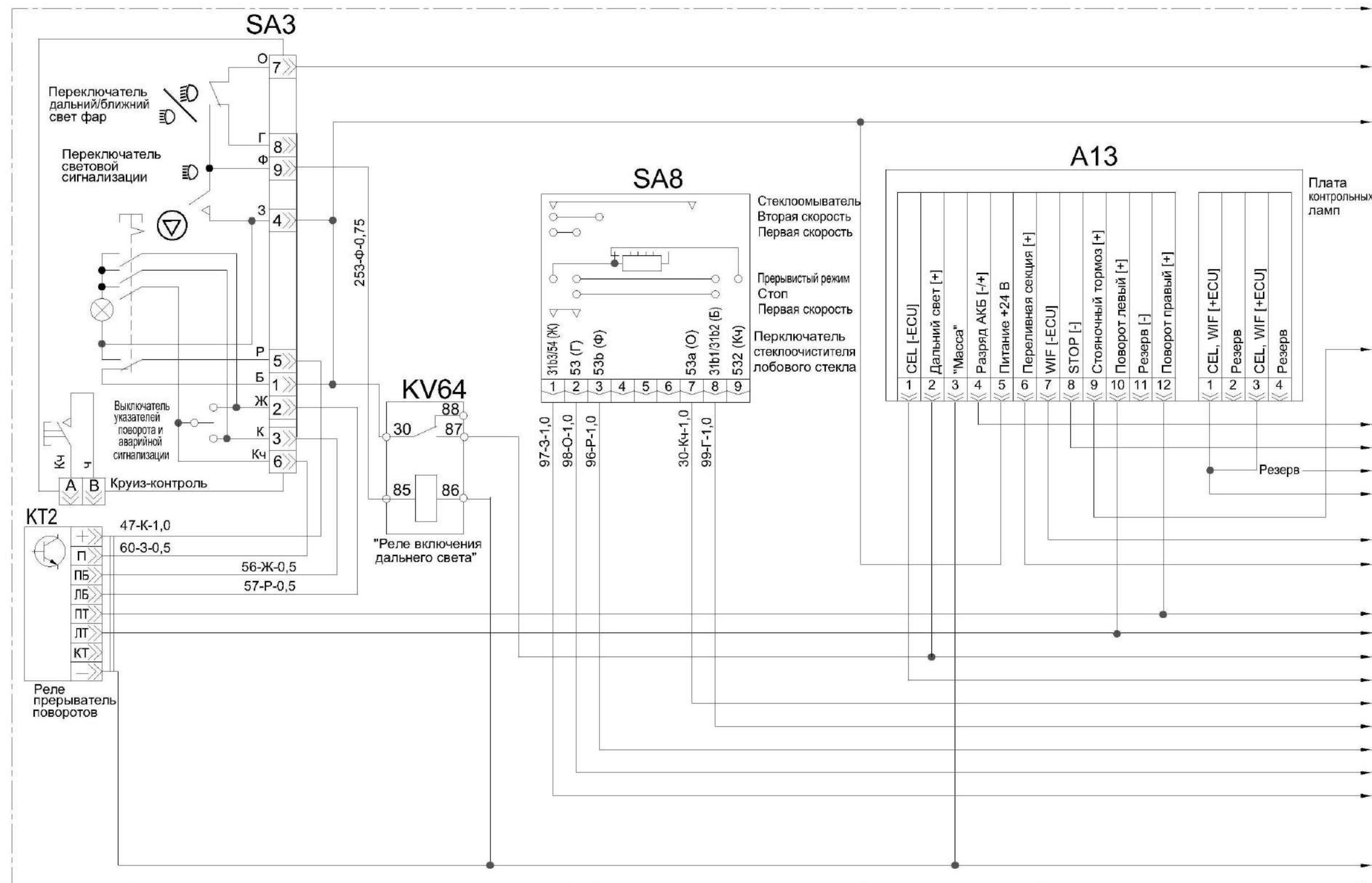
Рисунок Б.2 – Схема электрическая принципиальная комбайна (лист 2.1)
