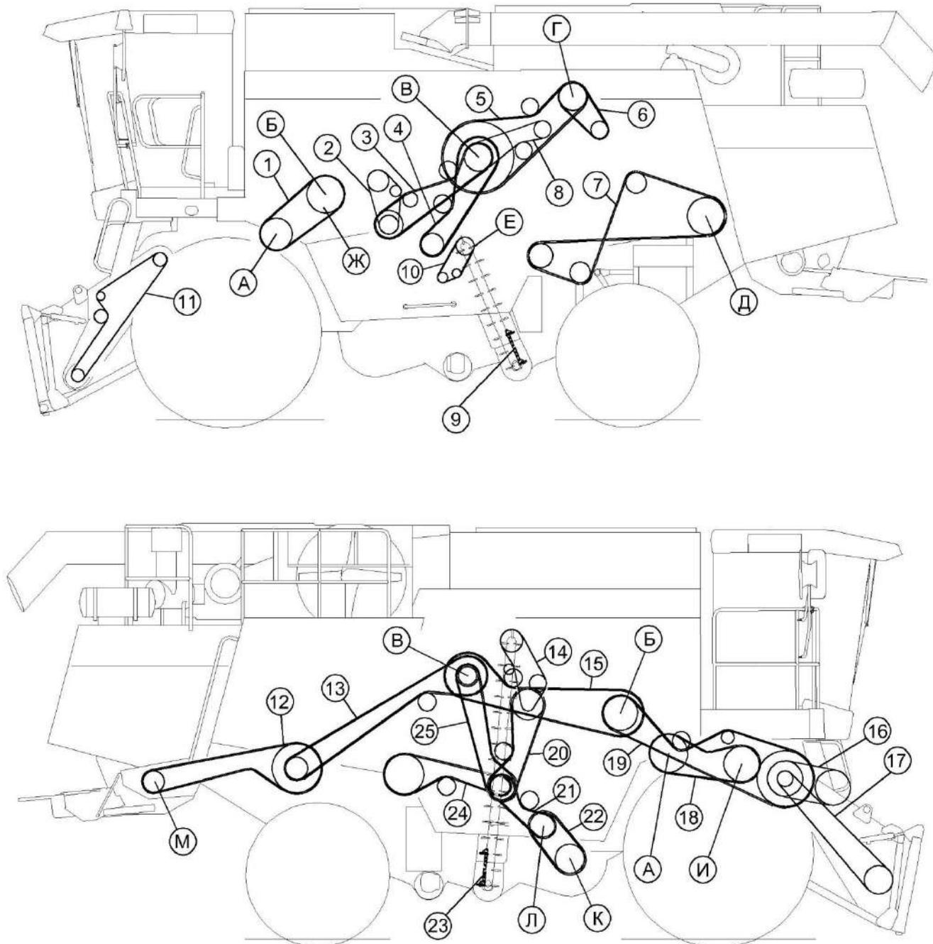
А – барабан молотильный; Б – отбойный битер; В – главный привод; Г – двигатель;
