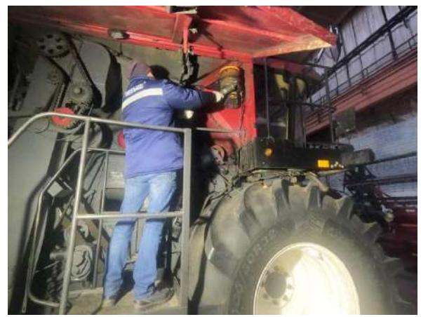
Рисунок 3.4 – Заправка насоса АЦСС
