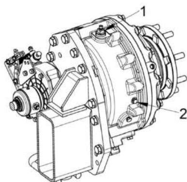
1 – отверстие для заправки; 2 – контрольное отверстие
