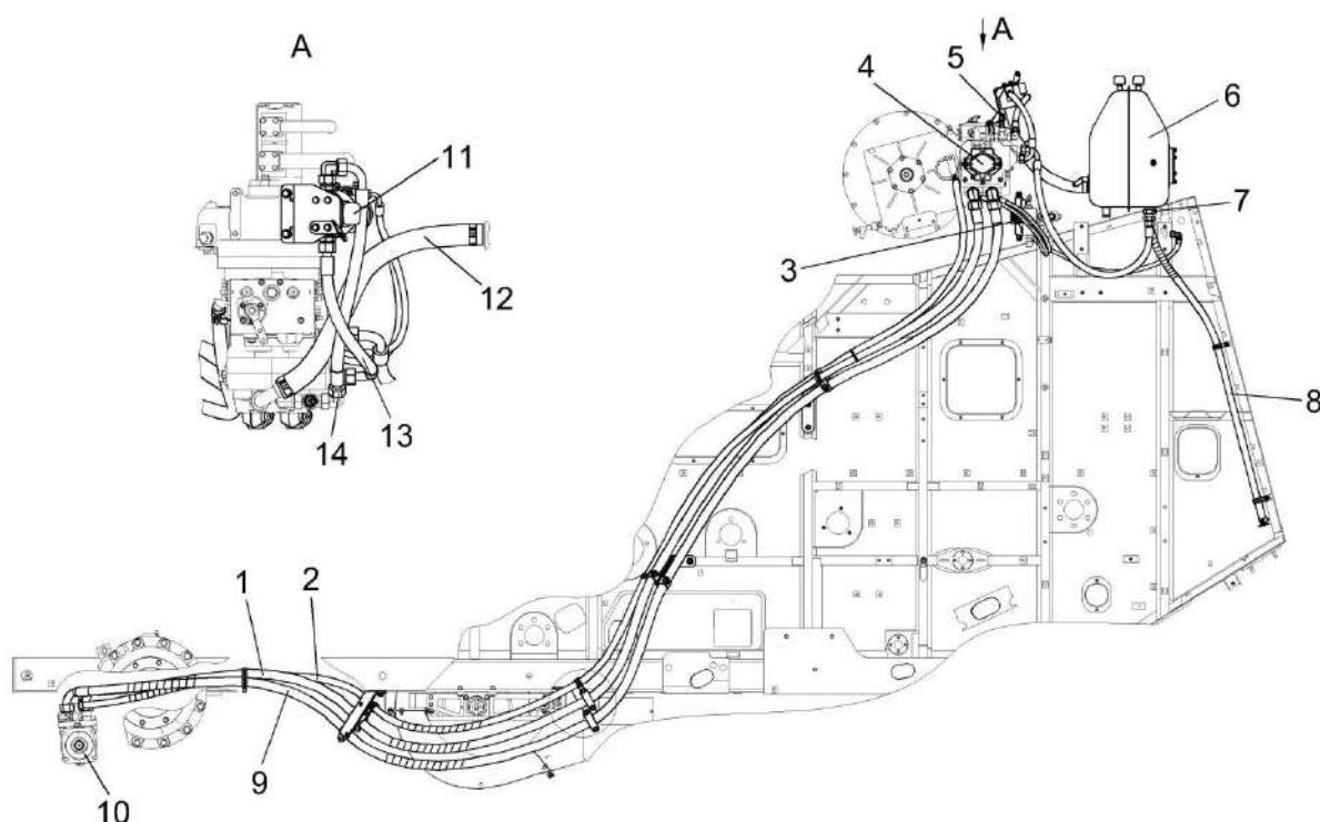
1, 9, 13, 14 – рукава высокого давления; 2, 8 – рукава; 3 – гидроблок доворота вала мотора ГСТ; 4 – гидронасос; 5 – точка диагностическая; 6 – бак масляный; 7 – гидроклапан обратный; 10 – гидромотор; 11 – фильтр напорный; 12 – рукав всасывающий
