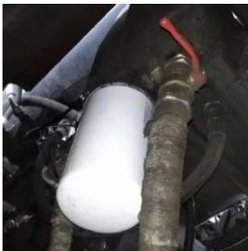
Рисунок 3.8 – Перекрытый кран сливного фильтроэлемента
