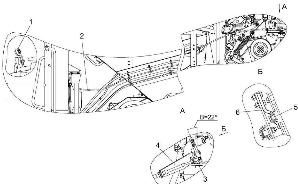
1 – рукоятка управления скоростью движения; 2 – трос; 3 – ось; 4 – кронштейн; 5 – вал управления; 6 – флагок гидронасоса
