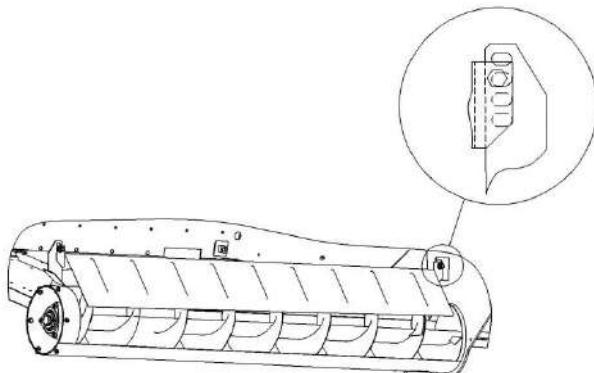
Рисунок 2.16 – Регулировка ограждения над горизонтальным шнеком бункера
