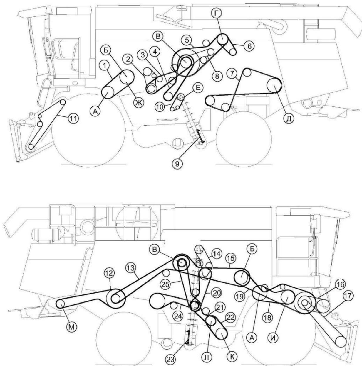
А – барабан молотильный; Б – отбойный бите; В – главный привод; Г – двигатель;
