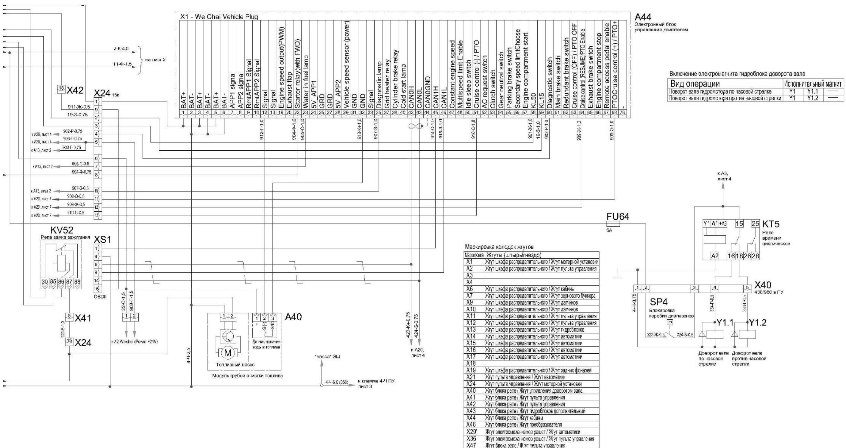
Рисунок Б.1 – Схема электрическая принципиальная комбайна (лист 1.2)
