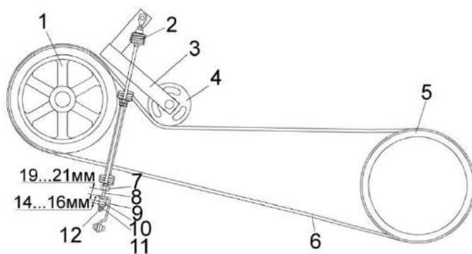
1, 5 – шкивы; 2 – пружина; 3 – рычаг; 4 – ролик натяжной; 6 – ремень; 7, 12 – контргайки; 8 – винт натяжной; 9 – зацеп; 10 – амортизатор; 11 – гайка
