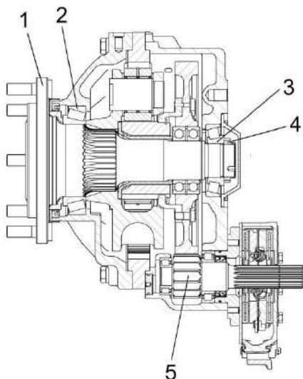
1 – колесо; 2, 3 – подшипники; 4 – гайка; 5 – вал-шестерня
