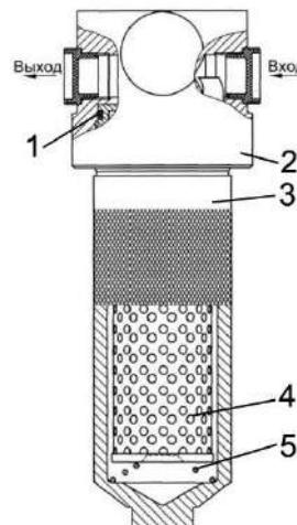
1 – комбинированное уплотнение стакана; 2 – головка (корпус) фильтра; 3 – стакан; 4 – фильтроэлемент; 5 – пружина
