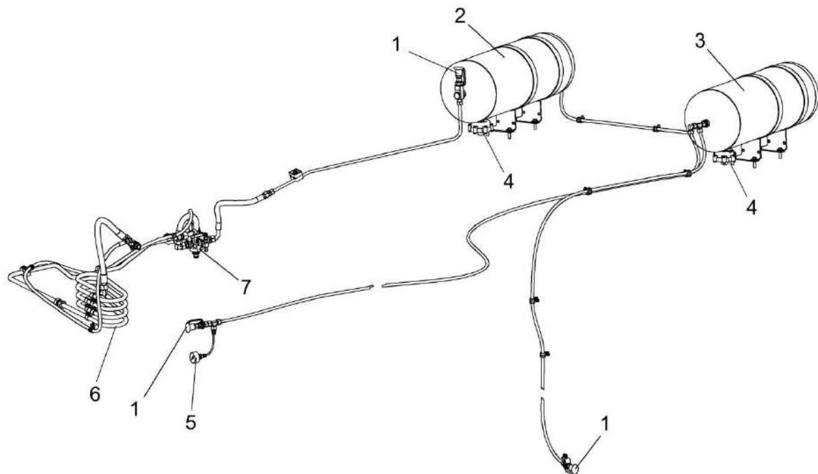
1 – пневмовыводы; 2, 3 – ресиверы; 4 – клапаны слива конденсата; 5 – манометр; 6 – трубопровод; 7 – регулятор давления
