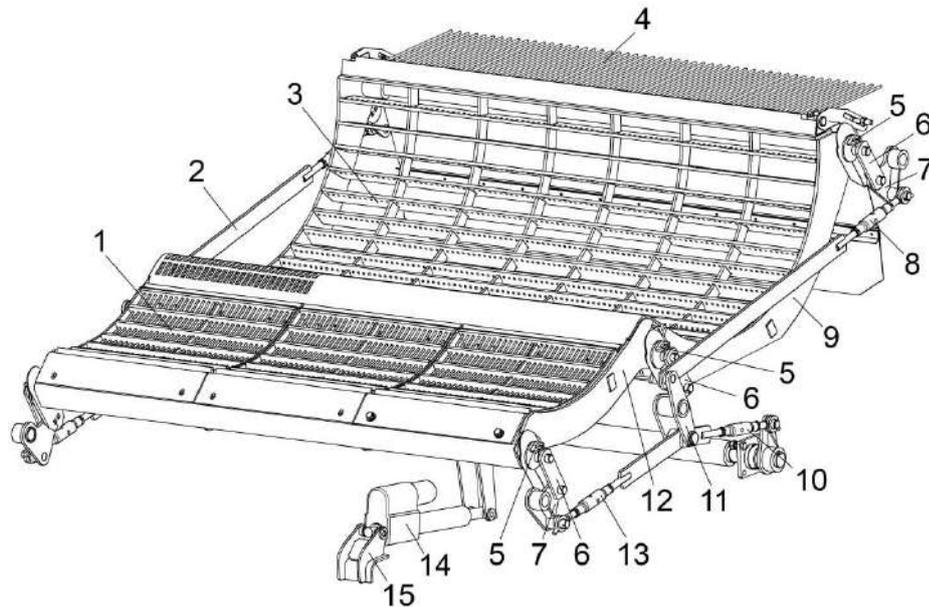
1 – деки переднего подбарабанья; 2, 8, 10, 13 – тяги; 3 – дека заднего подбарабанья; 4 – решетка пальцевая; 5 – фиксаторы; 6 – стяжки; 7, 11 – рычаги; 9 – каркас заднего подбарабанья; 12 – каркас переднего подбарабанья; 14 – электромеханизм; 15 – кронштейн
