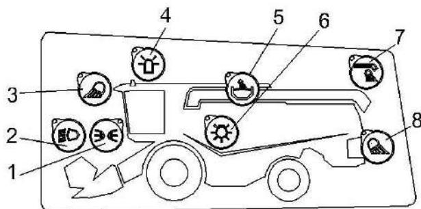
1 – выключатель габаритных огней; 2 – выключатель ближнего/дальнего света; 3 – выключатель передних рабочих фар (на кабине); 4 – выключатель проблесковых маяков; 5 – выключатель фары бункера; 6 – выключатель подкапотного освещения; 7 – выключатель фары выгрузного шнека; 8 – выключатель задних рабочих фар
