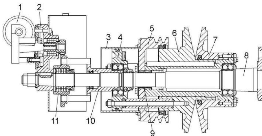
1, 2 – привод; 3 – кожух; 4 – корпус; 5, 6, 7 – шкивы; 8 – ось; 9, 10 – втулки; 11 – колесо
