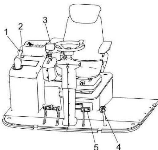
1 – рычаг переключения передач; 2 – выключатель зажигания; 3 – рукоятка управления скоростью движения; 4 – педаль стояночного тормоза; 5 – педаль блокировки коробки передач
