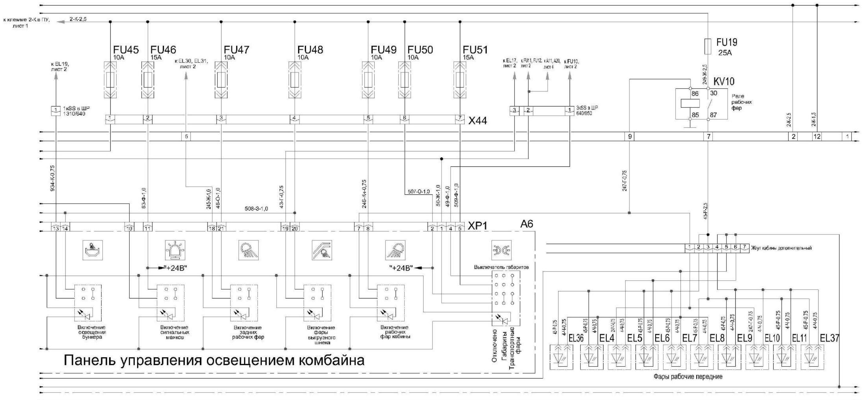
Рисунок Б.3 – Схема электрическая принципиальная комбайна (лист 3.2)
