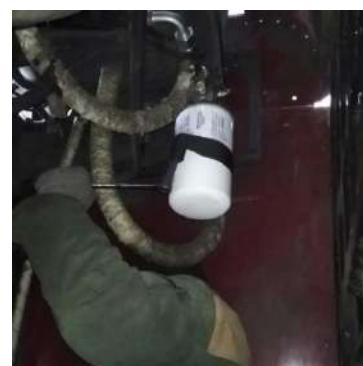
Рисунок 3.9 – Сливной фильтроэлемент, демонтируемый при помощи ключа фильтра
