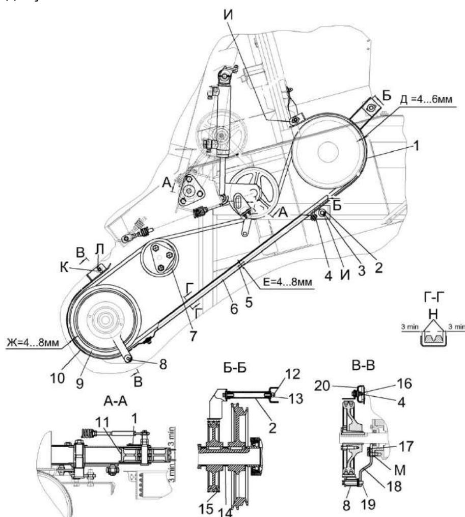
1, 10 – щитки; 2 – переходник; 3, 8 – втулки; 4, 12 – шайбы; 5 – ремень; 6 – направляющая; 7 – ролик обводной; 9, 15 – шкив; 11 – ролик натяжной; 13 – гайка; 14 – набор шайб; 16, 17, 19 – болты; 18, 20 – кронштейны; И, К, Л, М - овальные отверстия
