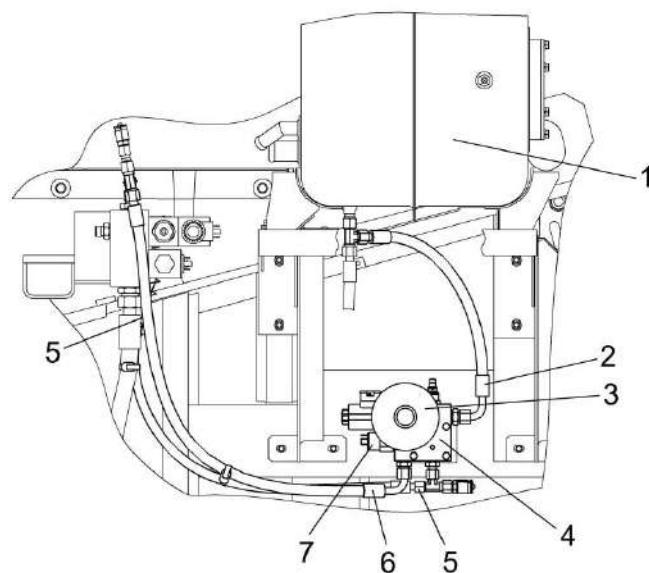
1 – бак масляный; 2, 5, 6 – рукава высокого давления; 3 – пневмогидроаккумулятор; 4 – гидроблок; 7 – реле давления
