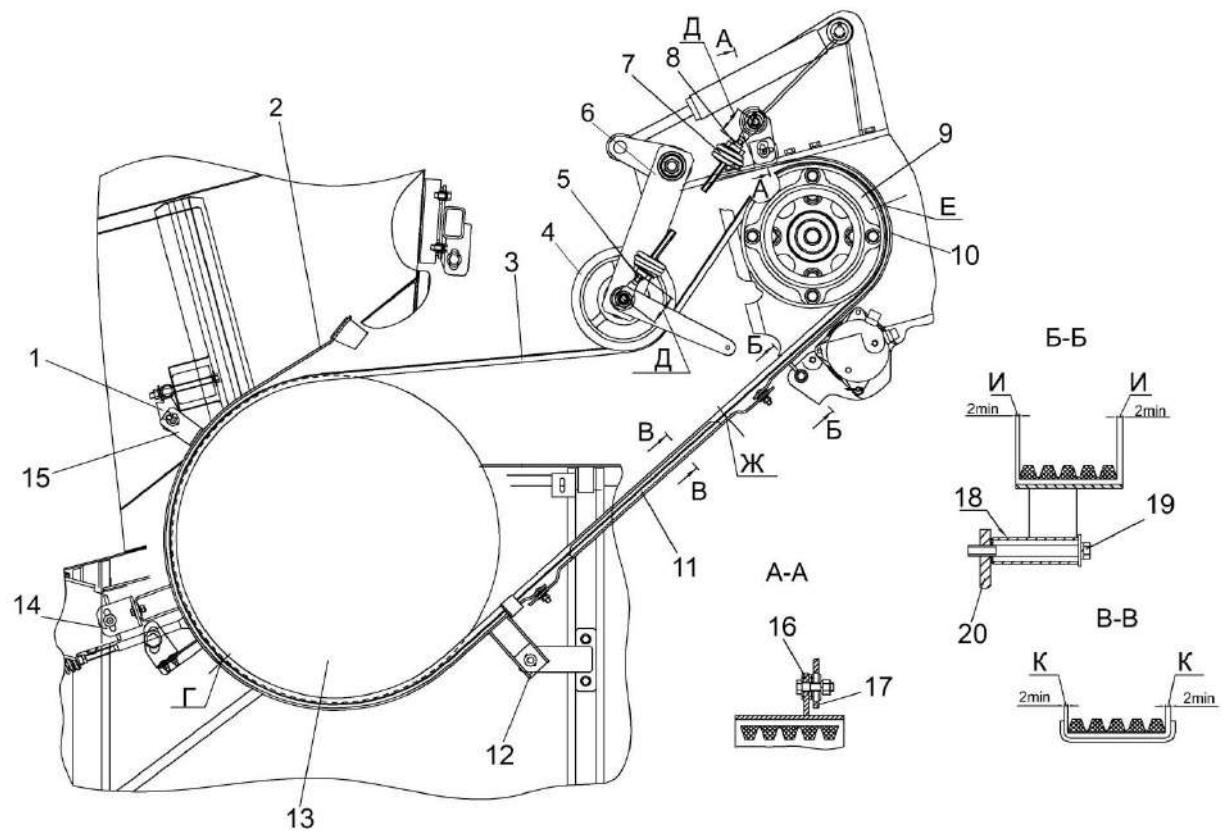
1, 12, 14, 15, 16, 17, 20 – кронштейны; 2, 10, 11 – щитки; 3 – ремень; 4 – ролик; 5, 8 – гайки; 6 – рычаг; 7 – пружина; 9, 13 – шкивы; 18 – втулка; 19 – болт
