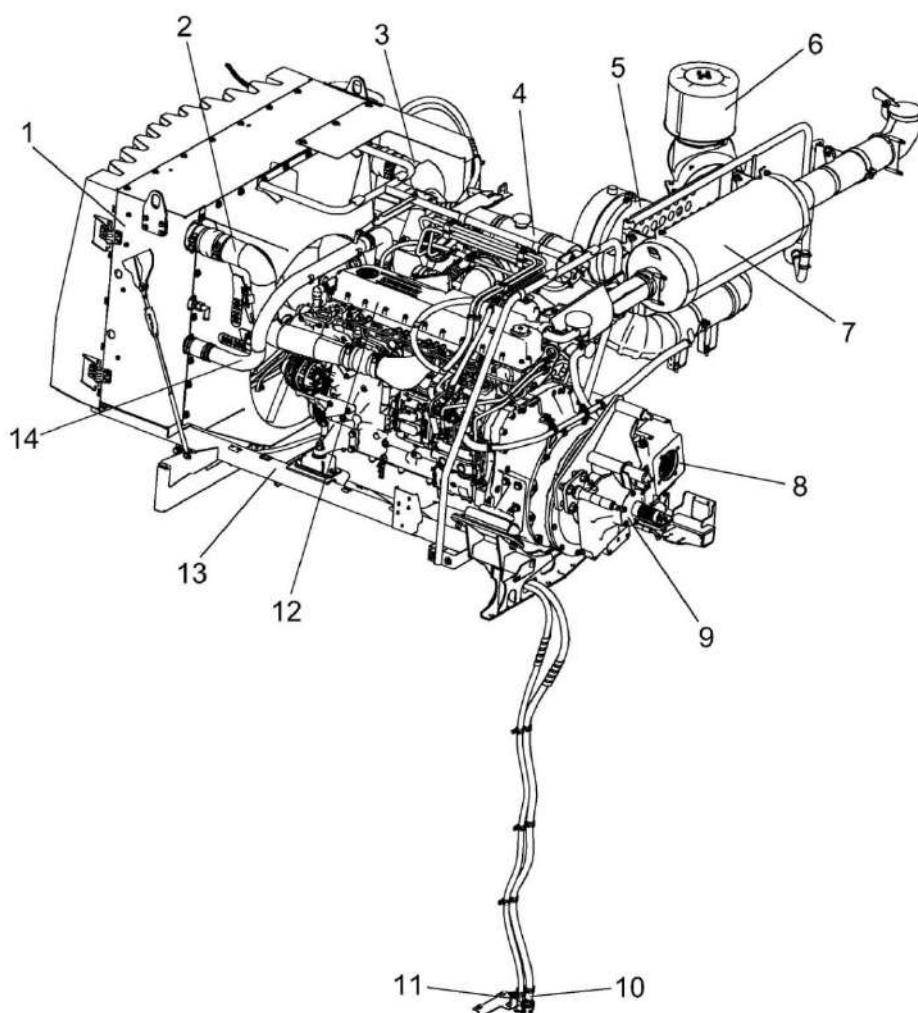
1 – радиатор; 2, 3 – трубы воздушные; 4 – бачок расширительный; 5 – фильтр воздушный; 6 – воздухозаборник вращающийся; 7 – глушитель; 8 – установка гидронасосов; 9 – главный привод; 10 – сливной рукав масла из редуктора и картера двигателя; 11 – сливной рукав охлаждающей жидкости; 12 – двигатель; 13 – рама подмоторная; 14 – труба водяная верхняя
