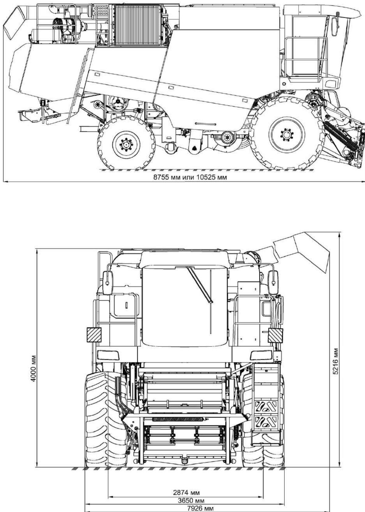
Рисунок 1.1 – Габаритные размеры комбайна
