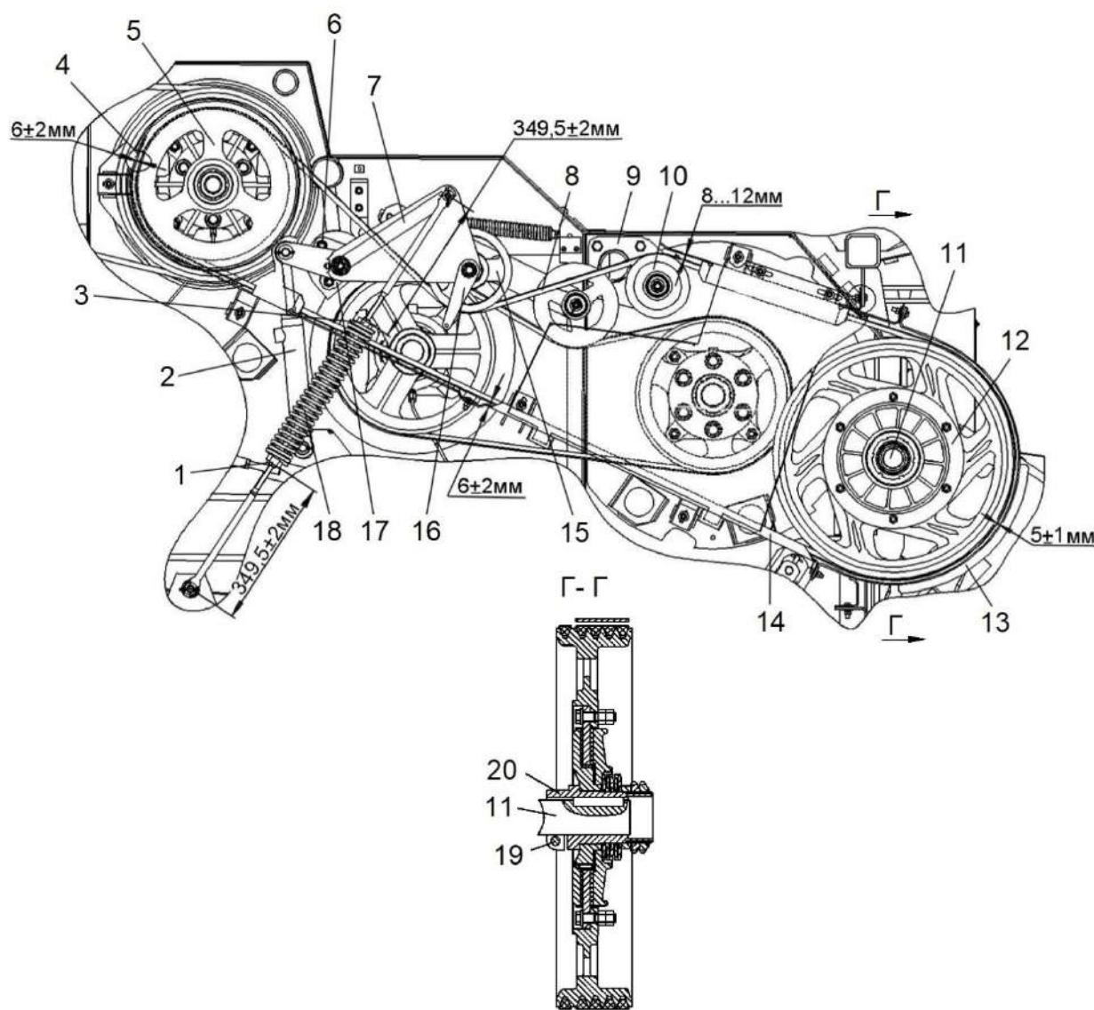
1, 3, 6 – гайки; 2 – гидроцилиндр; 4, 13, 14 – щитки; 5, 12 – шкивы; 7 – рычаг; 8 – ремень; 9, 17 – опора; 10, 15 – ролики; 11 – вал; 16 – кронштейн; 18 – пружина; 19 – болт; 20 - клемма
