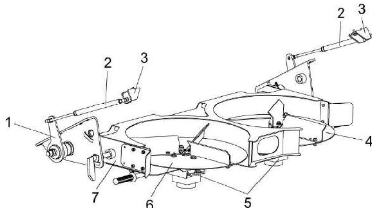
1 – рычаг; 2 – пружина газовая; 3 – кронштейн; 4 - диск правый; 5 – гидромоторы; 6 – диск левый; 7 – рама
