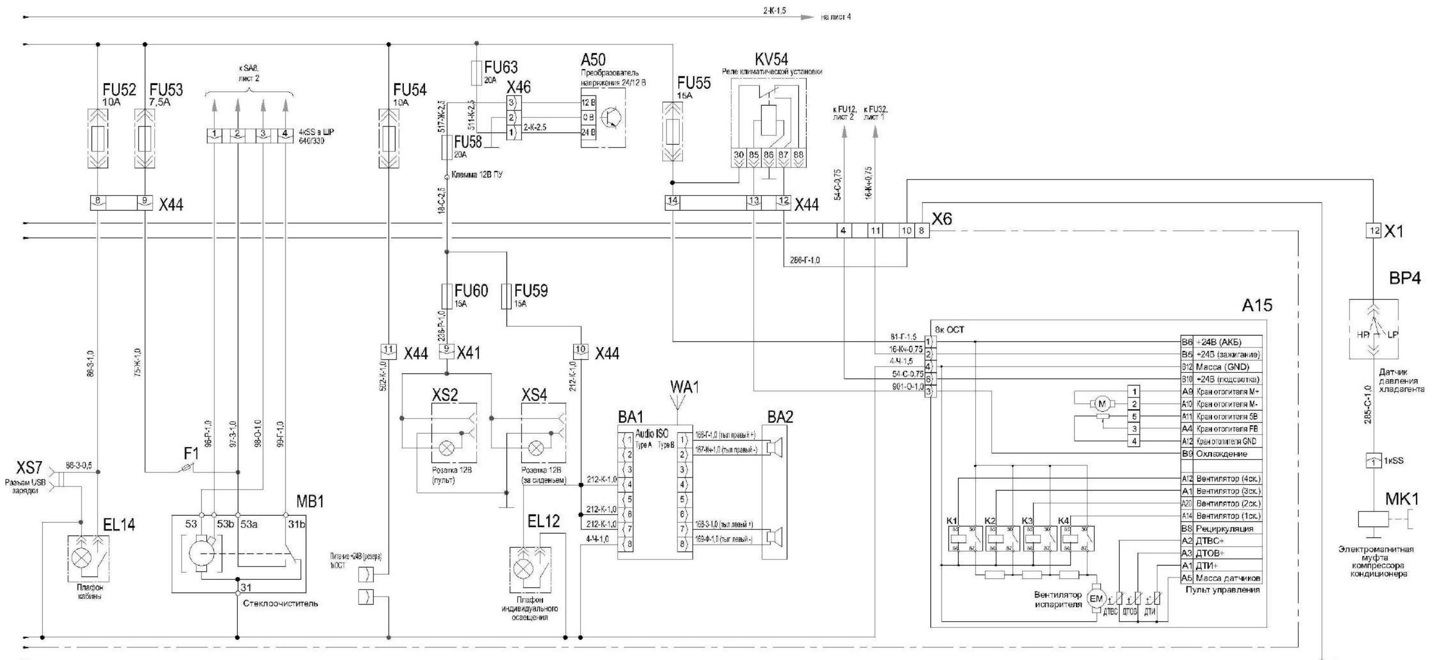
Рисунок Б.3 – Схема электрическая принципиальная комбайна (лист 3.3)
