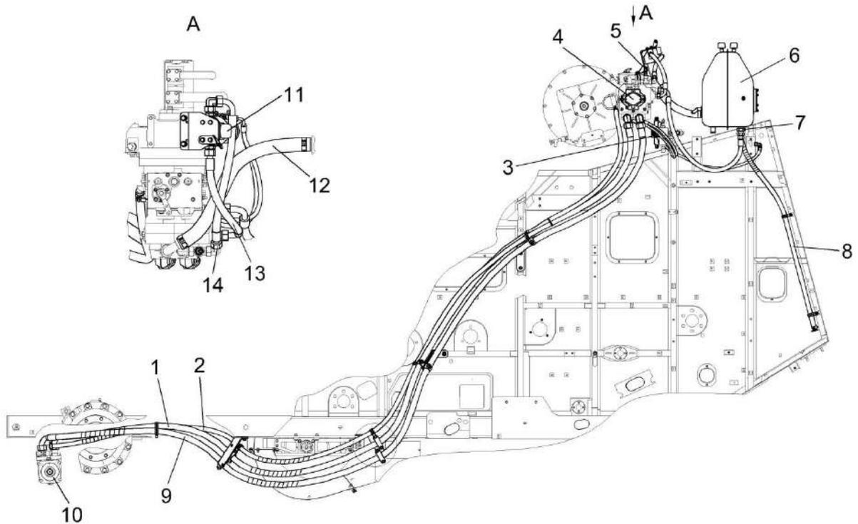
1, 9, 13, 14 – рукава высокого давления; 2, 8 – рукава; 3 – гидроблок доворота вала мотора ГСТ; 4 – гидронасос; 5 – точка диагностическая; 6 – бак масляный; 7 – гидроклапан обратный; 10 – гидромотор; 11 – фильтр напорный; 12 – рукав всасывающий
