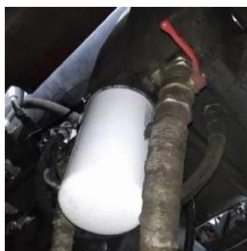
Рисунок 3.8 – Перекрытый кран сливного фильтроэлемента
