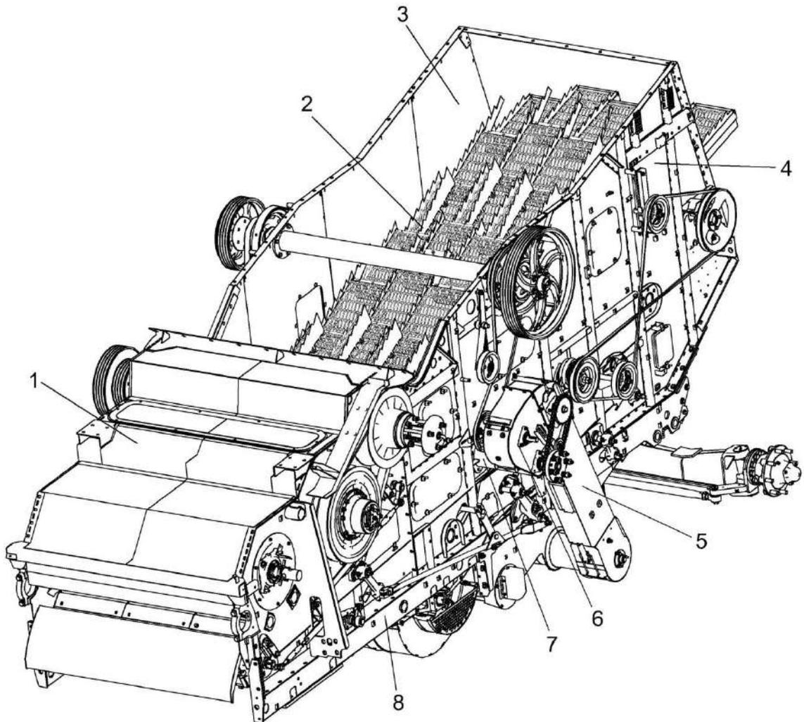
1 – молотильный аппарат; 2 – соломотряс; 3 – боковина правая; 4 – боковина левая; 5 – элеватор колосовой; 6 – устройство домолачивающее; 7 – шнек распределительный; 8 – шасси
