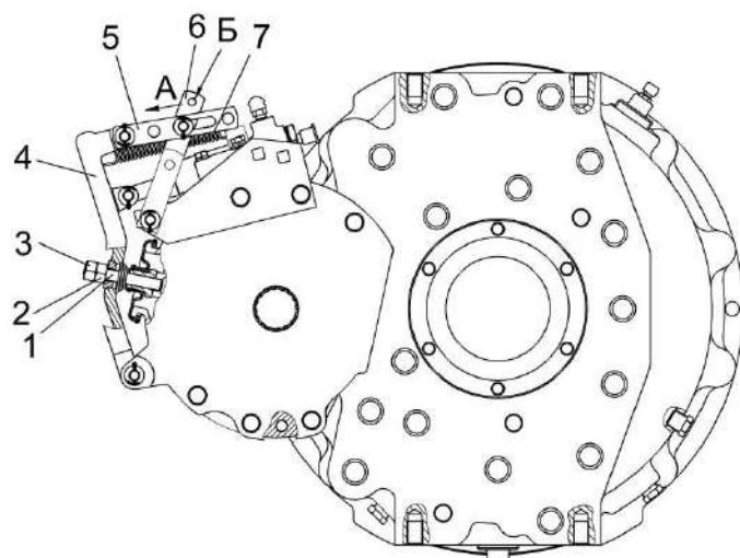
1, 5, 6 – тяги; 2 – гайка; 3 – контргайка; 4 – рычаг; 7 – пружина; Б - отверстие
