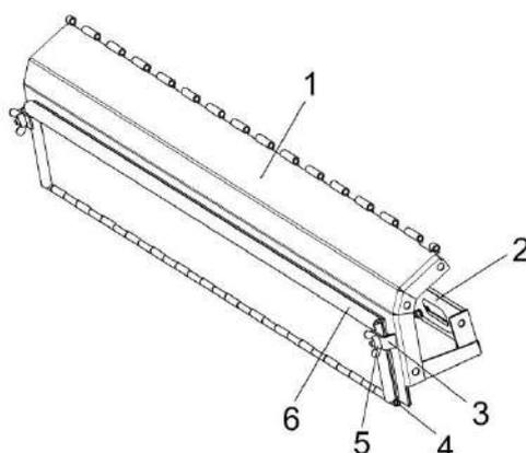
1 – основание; 2 – щит; 3 – прижим; 4 – ось; 5 – гайка-барашек; 6 – крышка
