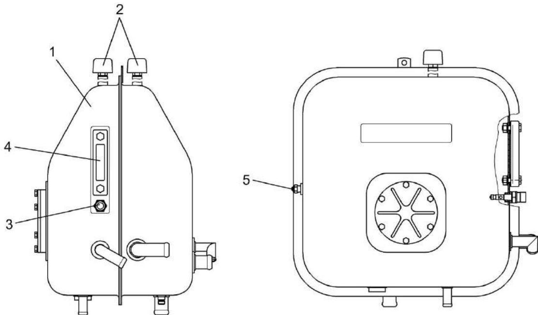
1 – бак масляный; 2 – фильтры воздушные; 3 – датчик аварийного уровня масла; 4 – указатель уровня масла; 5 – датчик аварийной температуры масла
