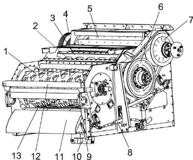
1 – барабан ускоряющий; 2 – барабан молотильный; 3 – бич; 4 – шкив; 5 – отбойный битер; 6, 7 – вариаторы барабана; 8 – механизм подъема подбарабаний; 9 – камнеуловитель; 10 – электромеханизм; 11 – щиток; 12 – рама; 13 – подбарабанье
