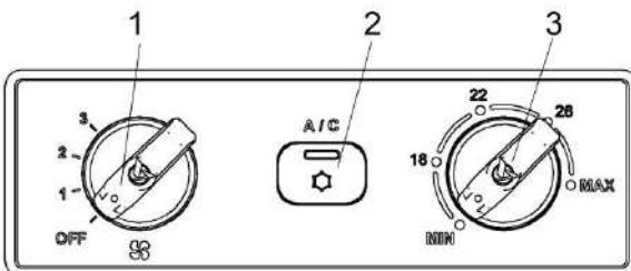
1 – ручка управления вентилятором; 2 – кнопка включения кондиционера; 3 – ручка управления термостатом кондиционера
