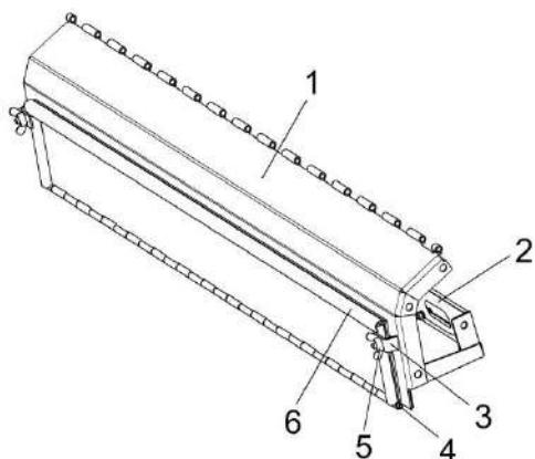
1 – основание; 2 – щит; 3 – прижим; 4 – ось; 5 – гайка-баращек; 6 – крышка
