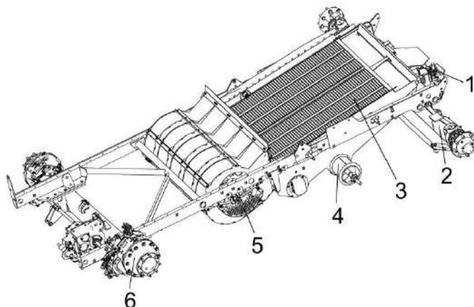
1 – устройство прицепное; 2 – мост управляемых колес; 3 – стан решетный нижний; 4 – блок шнеков; 5 – вентилятор; 6 – мост ведущих колес
