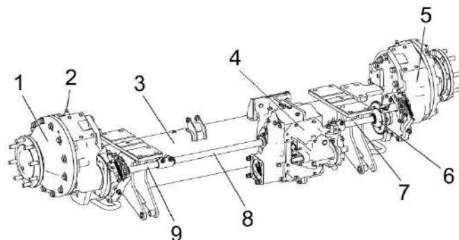
1, 5 – редукторы бортовые; 2 – сапун; 3 – балка; 4 – коробка передач; 6 – муфта; 7, 8, 9 – полуоси
