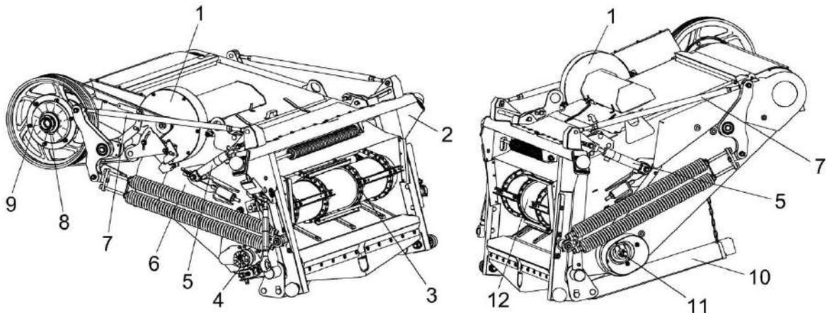
1 – вентилятор; 2 – рамка переходная; 3 – транспортер; 4 – гидрореверс; 5 – гидравлическая система; 6 – рама; 7 – механизм продольного копирования; 8 – вал верхний; 9 – муфта предохранительная; 10 – упор; 11 – вал трансмиссионный; 12 – вал нижний
