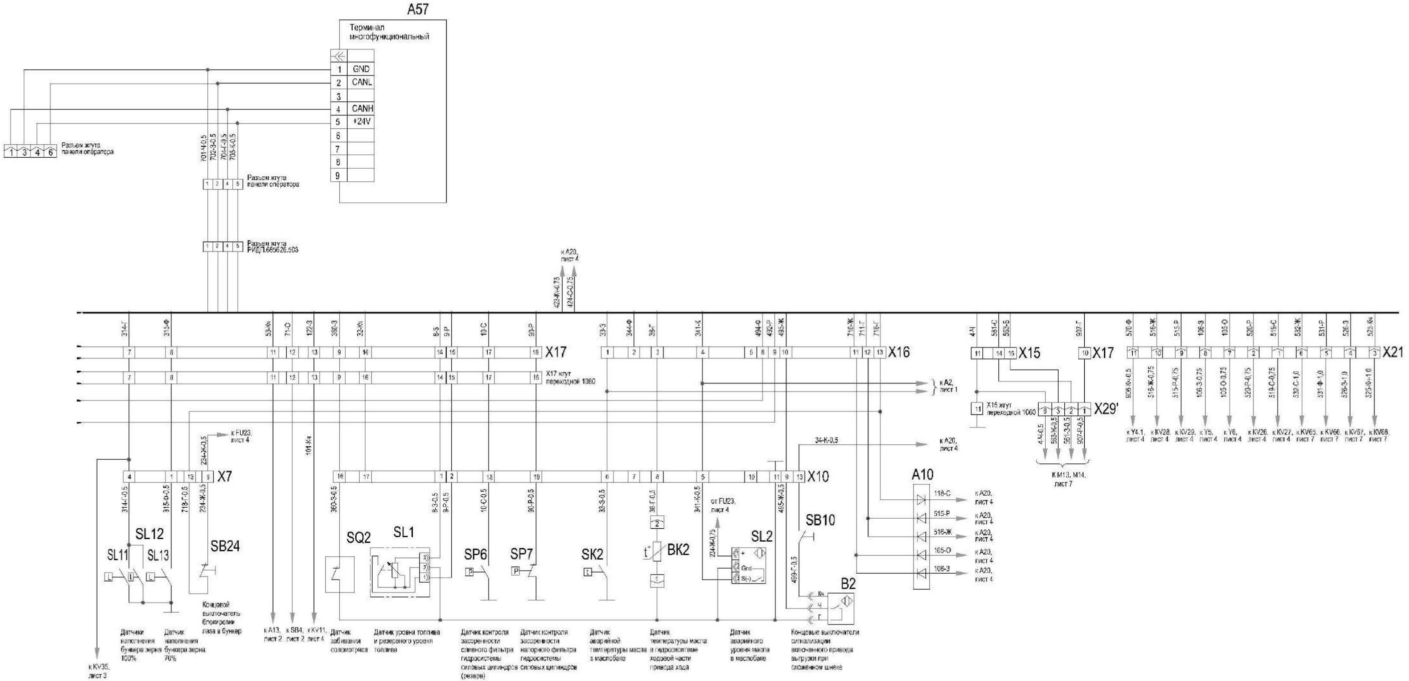
Рисунок Б.5 – Схема электрическая принципиальная комбайна (лист 5.2)
