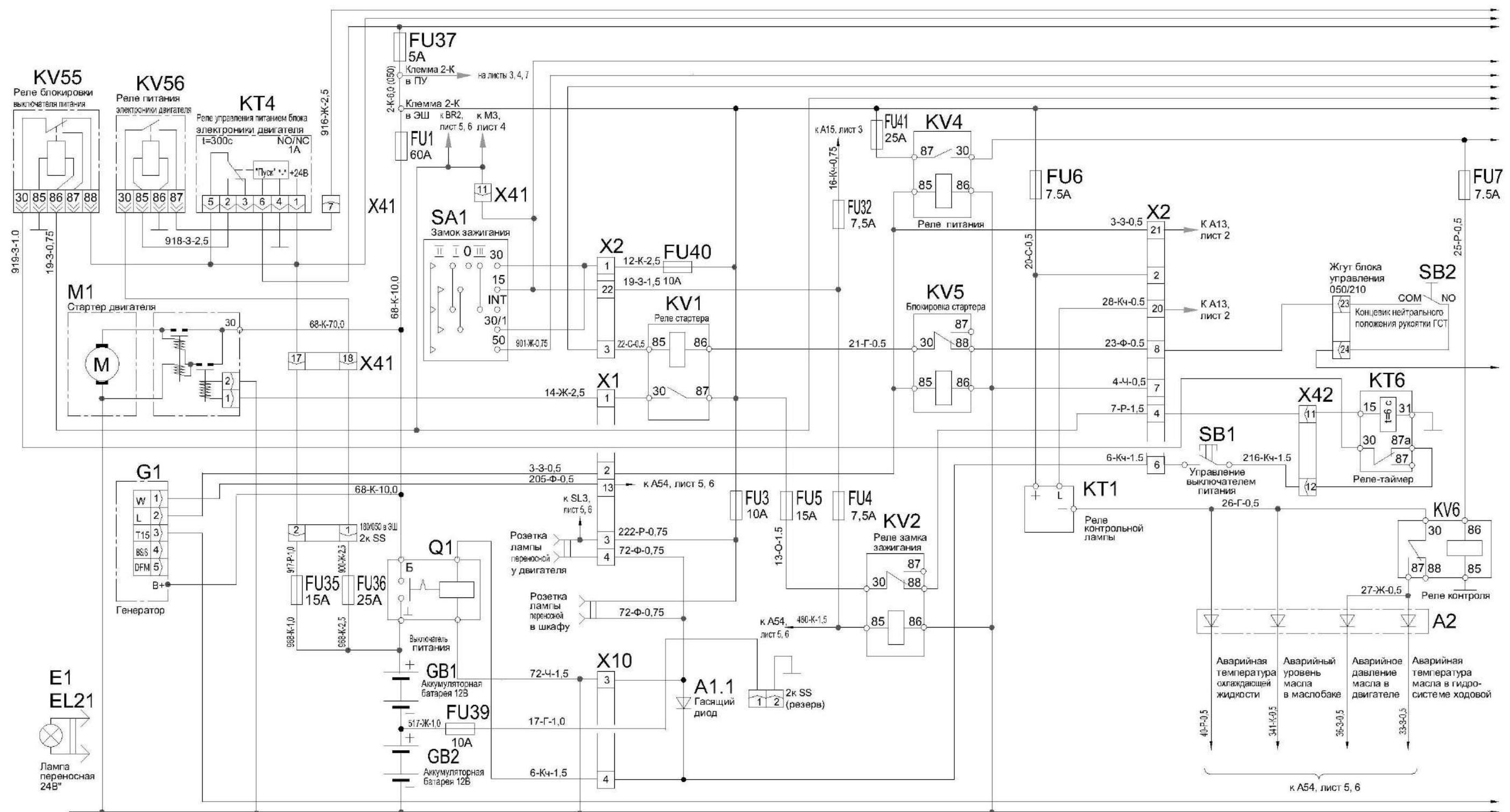
Рисунок Б.1 – Схема электрическая принципиальная комбайна (лист 1.1)
