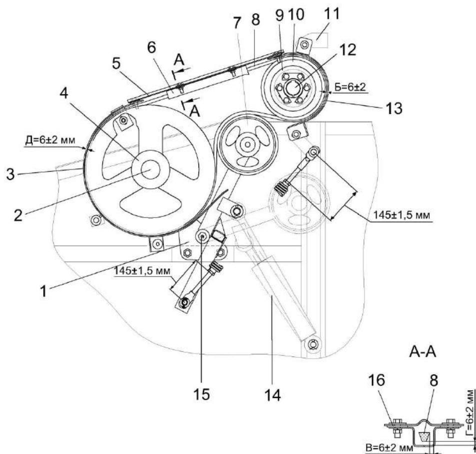
1 – опора; 2 – ось; 3, 13 – щитки; 4, 10 – шкивы; 5 – пластина; 6, 11 – кронштейны; 7 – ролик натяжной; 8 – ремень; 9 – ступица; 12 – вал; 14 - гидроцилиндр; 15 – гайка; 16 – шайба
