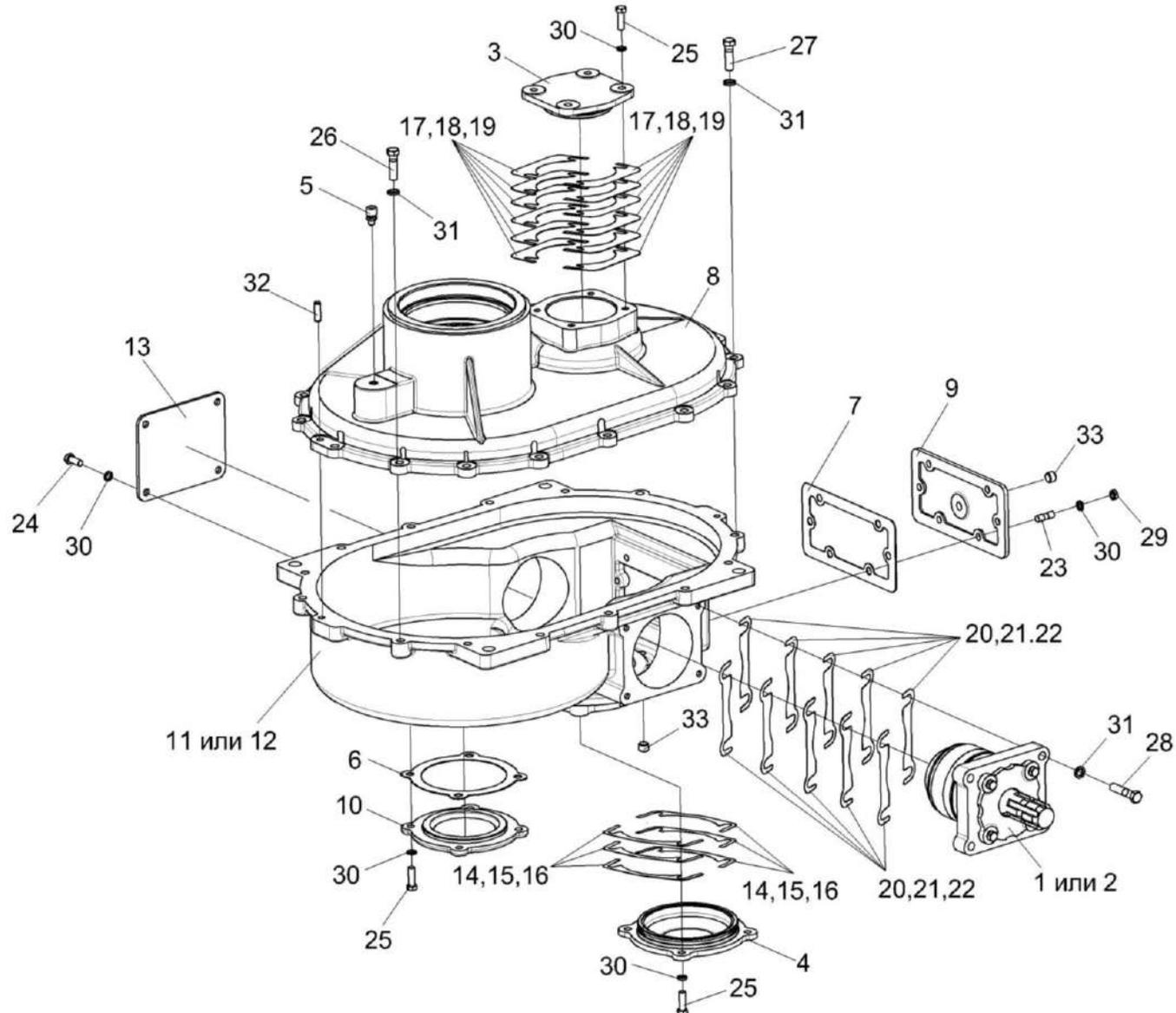
Рисунок 12 – Редуктор ЖГР-1-0203500 и ЖГР-1-0203500-01 (корпус и крышки)
