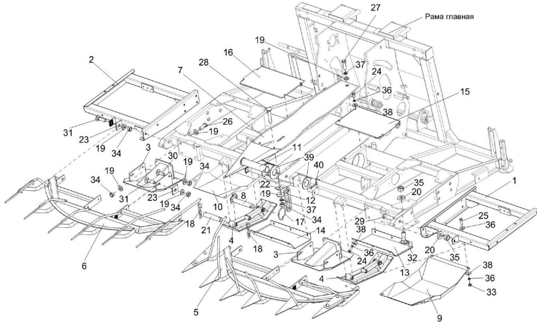
Рисунок 6 – Установка подрамников, башмаков и гребенок
