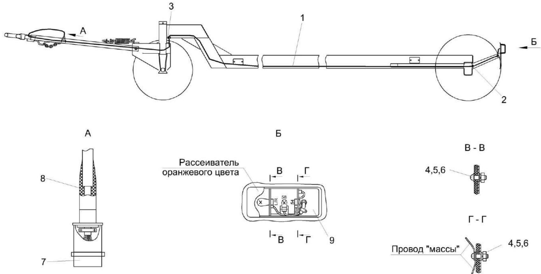
Рисунок 32 – Электрооборудование тележки транспортной ЖГР-3-0715900
