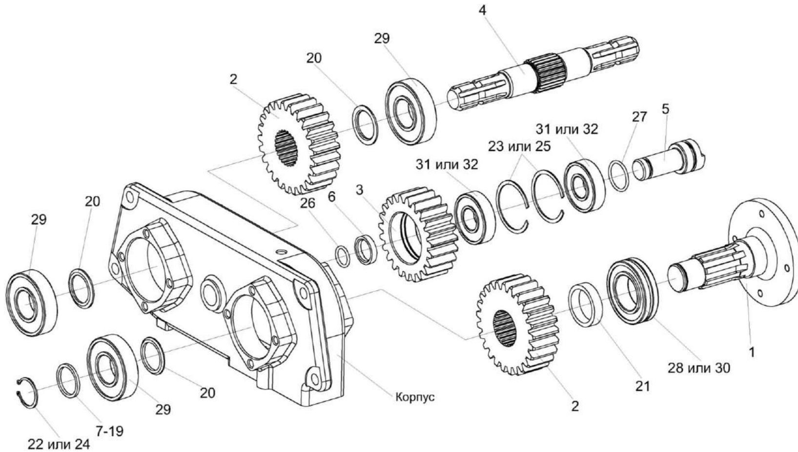
Рисунок 18 – Редуктор ЖГР-1-0204000-01 (валы и шестерни)
