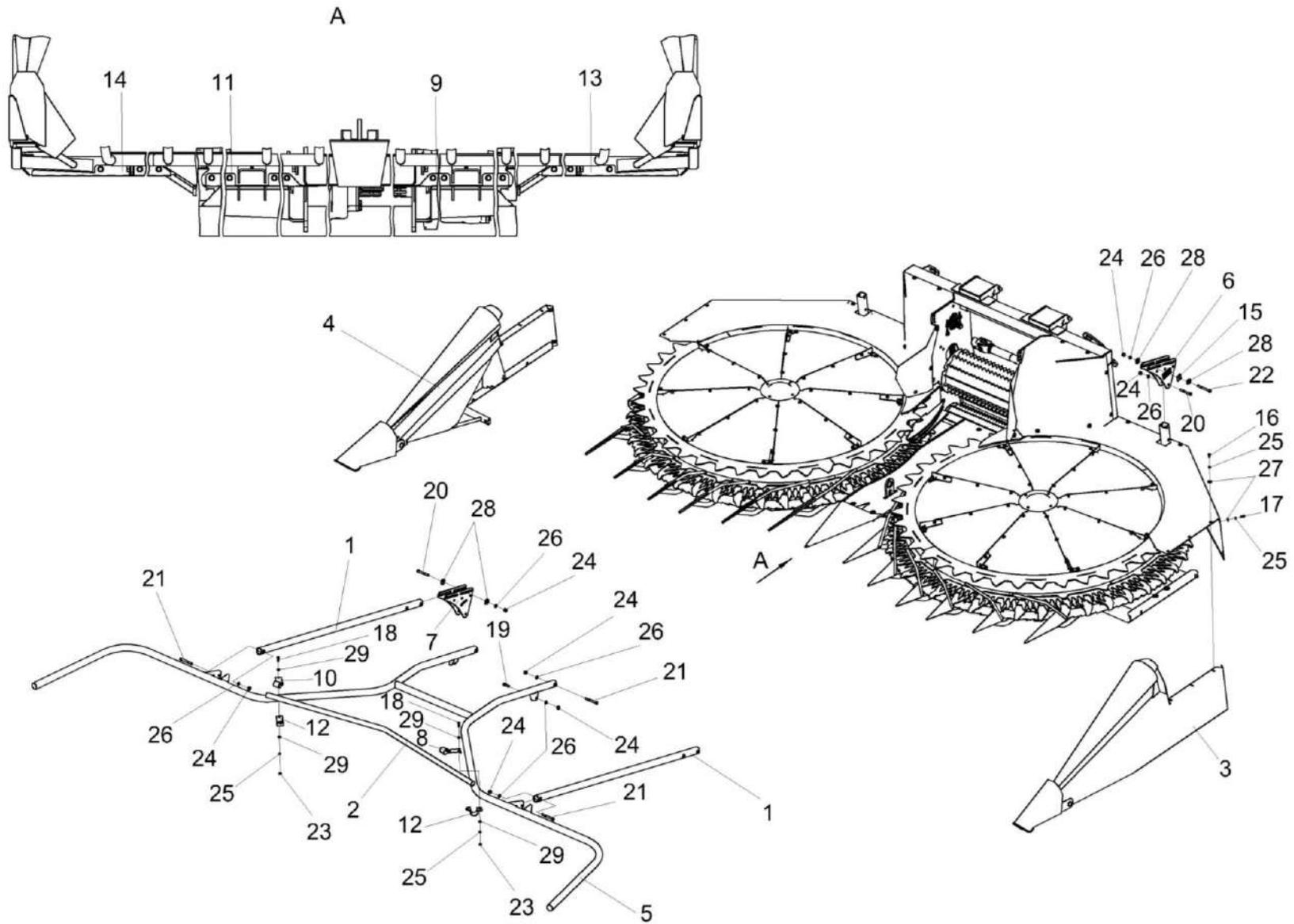
Рисунок 3 – Установка ограждений, кожухов, зашивки (лист 1)
