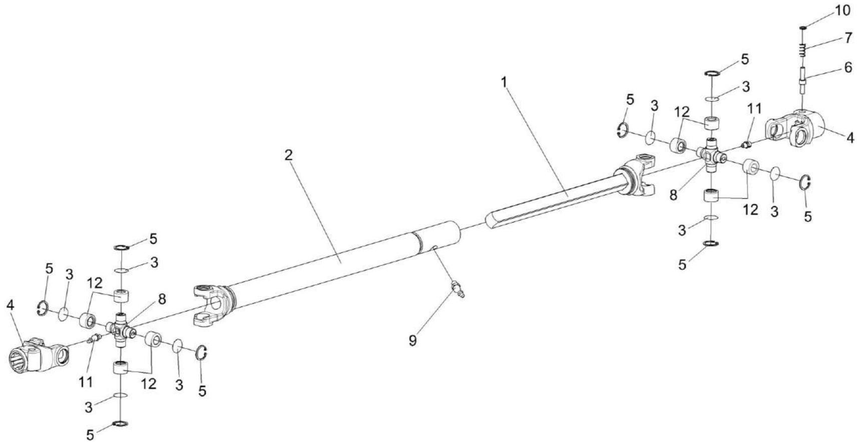
Рисунок 26 – Вал карданный телескопический ПКК 0140110-14
