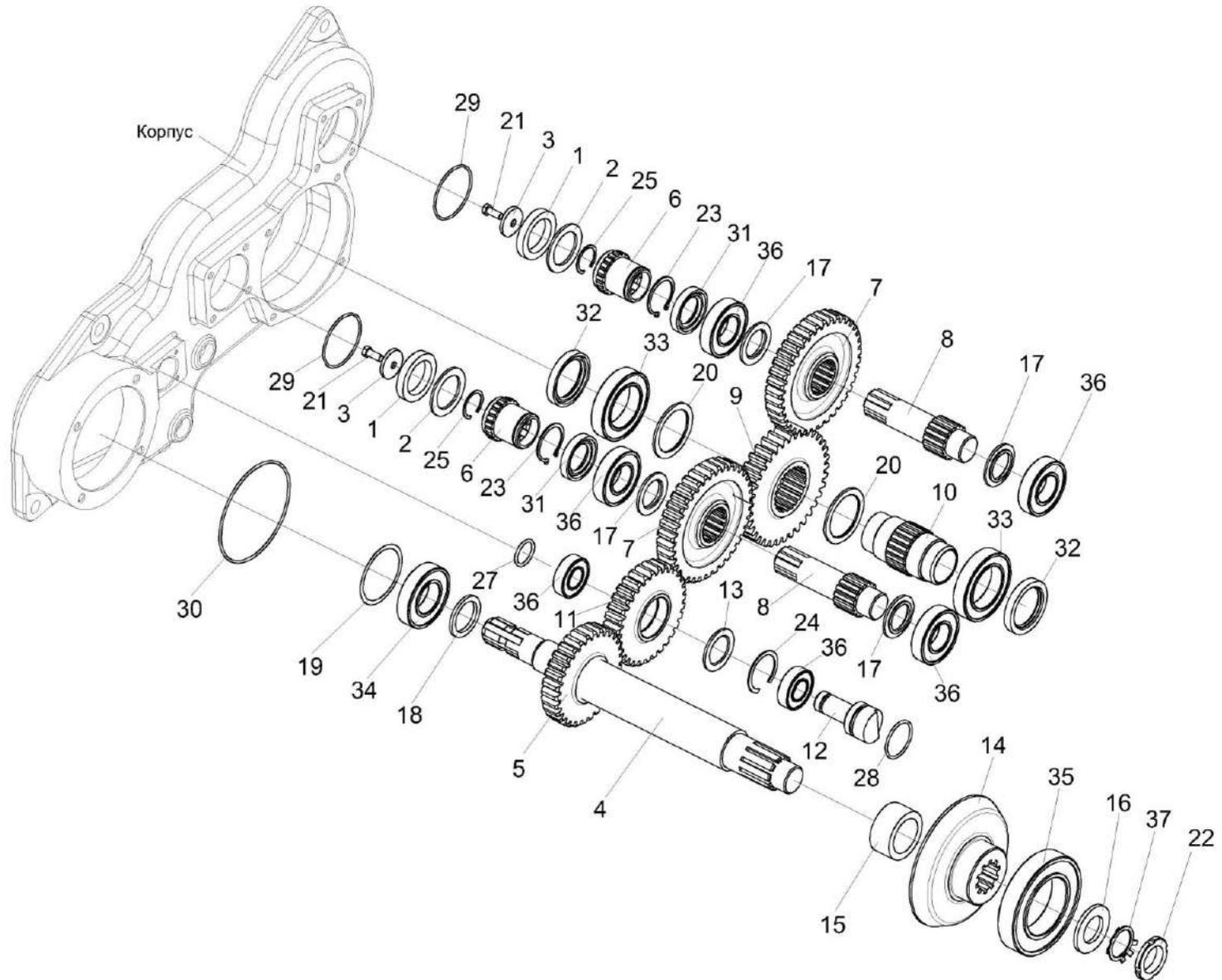
Рисунок 10 – Редуктор ЖГР-1-0202100 (валы и шестерни)
