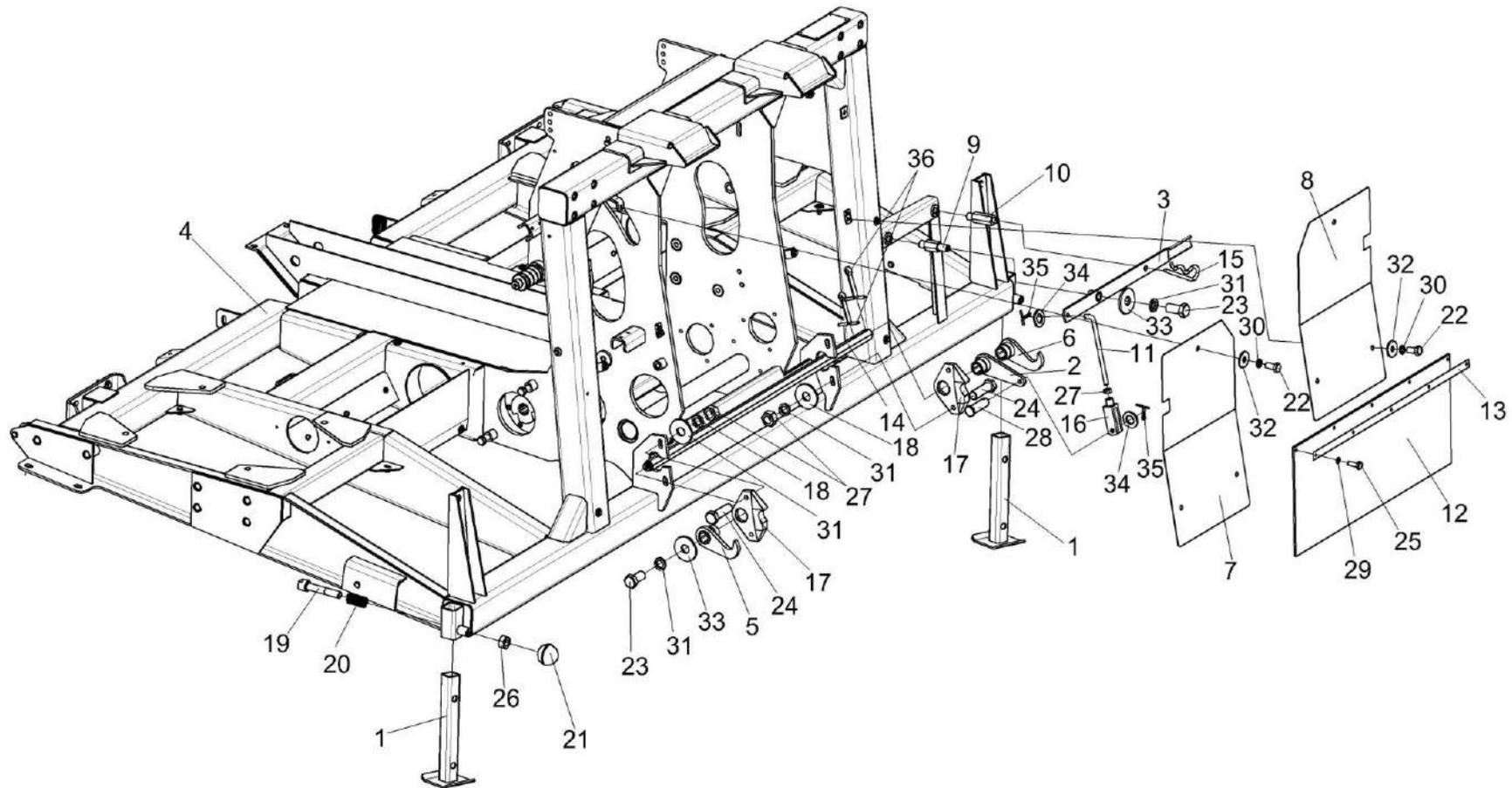
Рисунок 7 – Установка механизма фиксации
