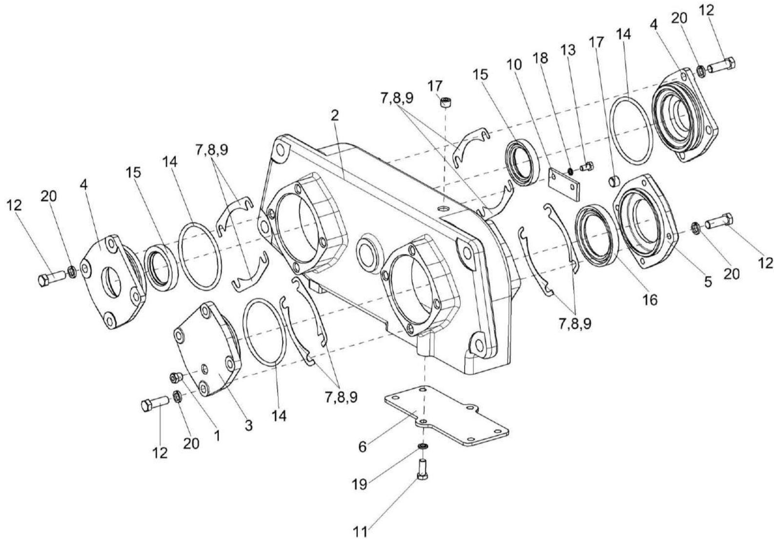
Рисунок 17 – Редуктор ЖГР-1-0204000-01 (корпус и крышки)
