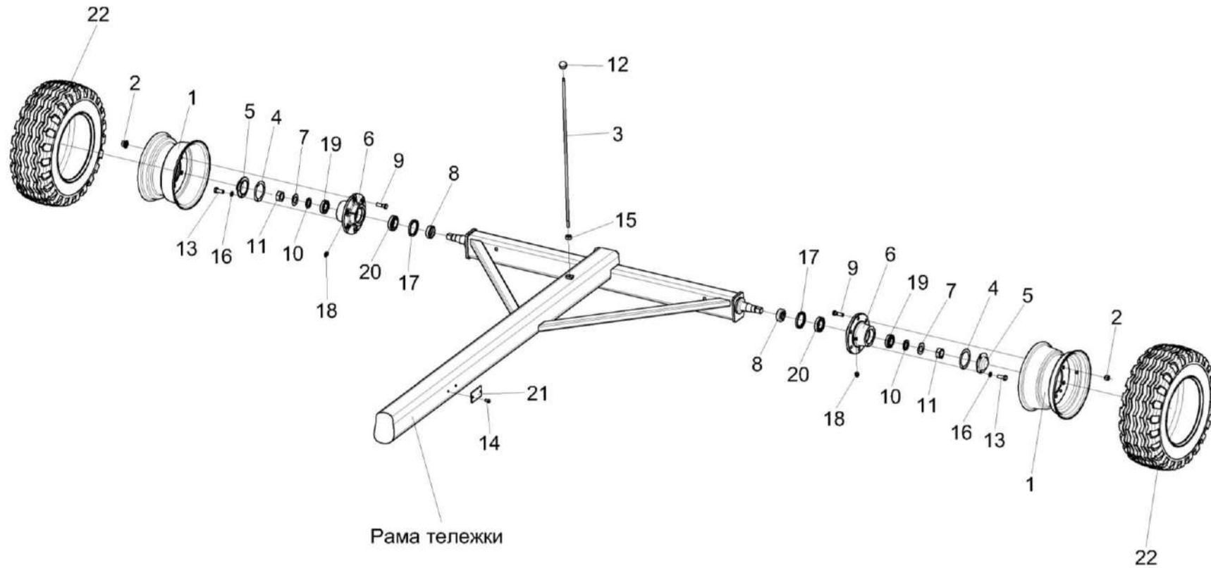
Рисунок 31 – Установка задних колес тележки транспортной
