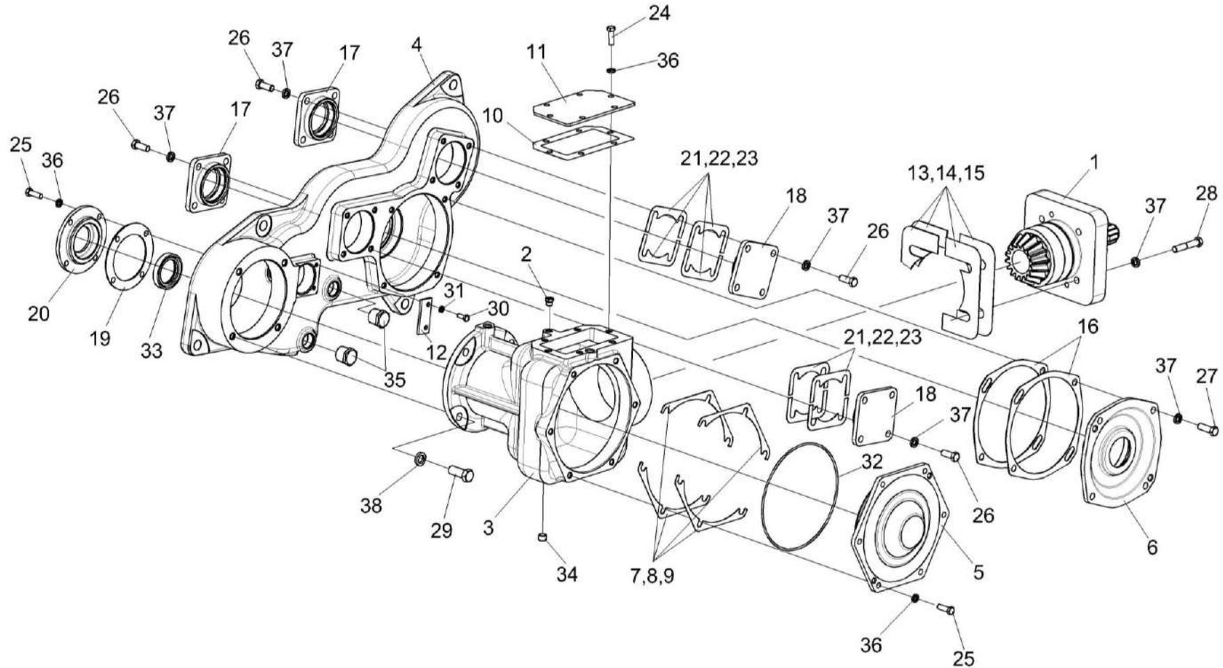
Рисунок 9 – Редуктор ЖГР-1-0202100 (корпуса и крышки)
