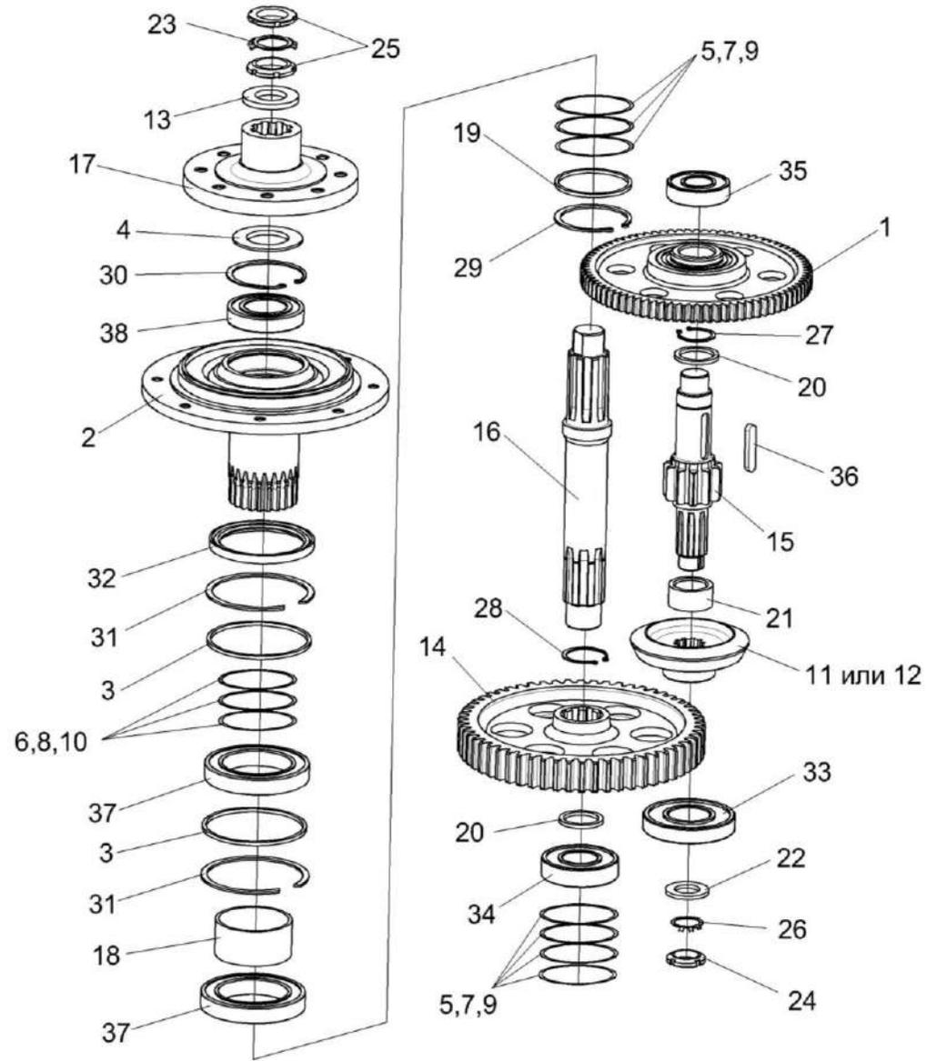
Рисунок 13 – Редуктор ЖГР-1-0203500 и ЖГР-1-0203500-01 (валы и шестерни)
