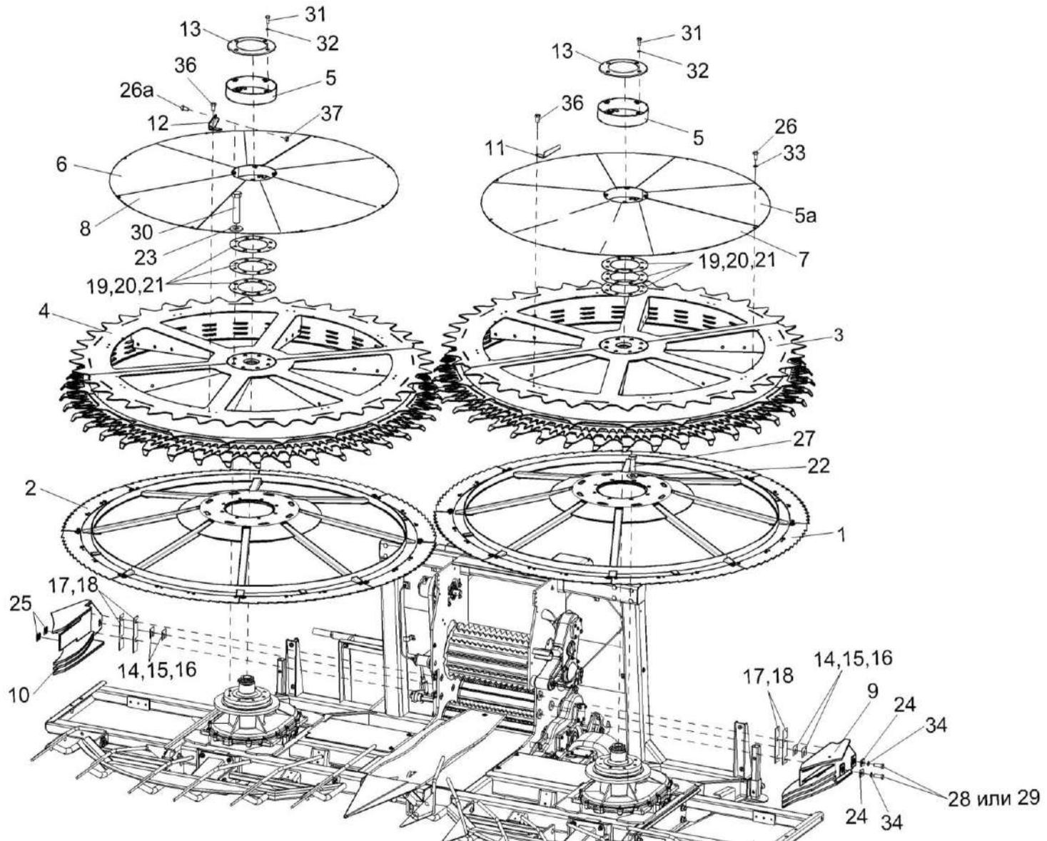
Рисунок 5 – Установка роторов
