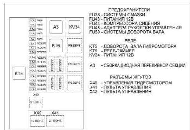
Рисунок 1.31 – Реле и предохранители пульта управления
