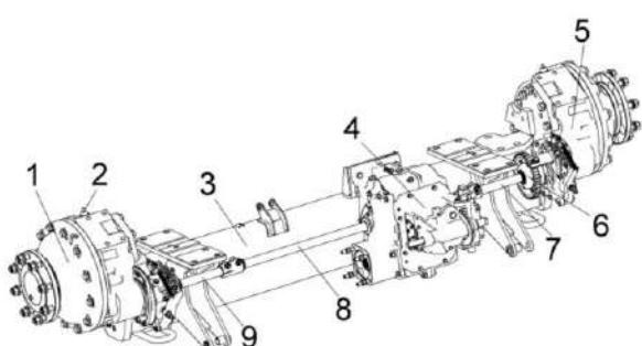
1, 5 – бортовые редукторы; 2 – сапун; 3 – балка; 4 – коробка передач; 6 – муфта; 7, 8, 9 – полуоси
