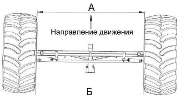
Рисунок 2.17 - Регулировка сходимости колес
