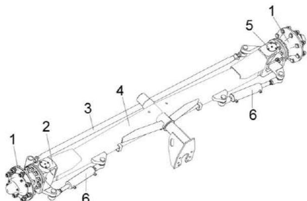
1 - ступица; 2, 5 - поворотный кулак; 3 - тяга рулевая; 4 – балка; 6 – гидроцилиндр
