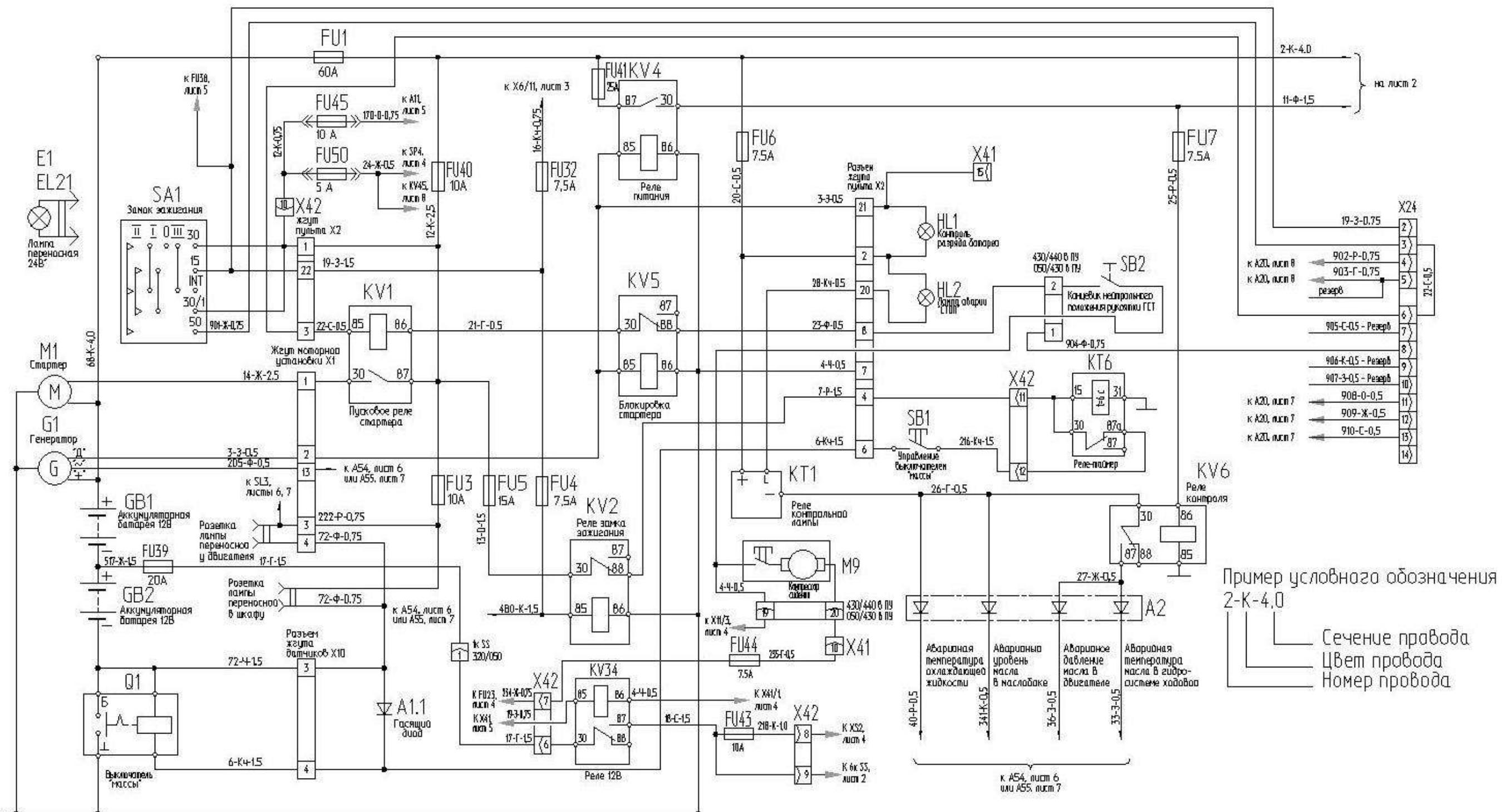
Рисунок Б.1 – Схема электрическая принципиальная комбайна (лист 1)
