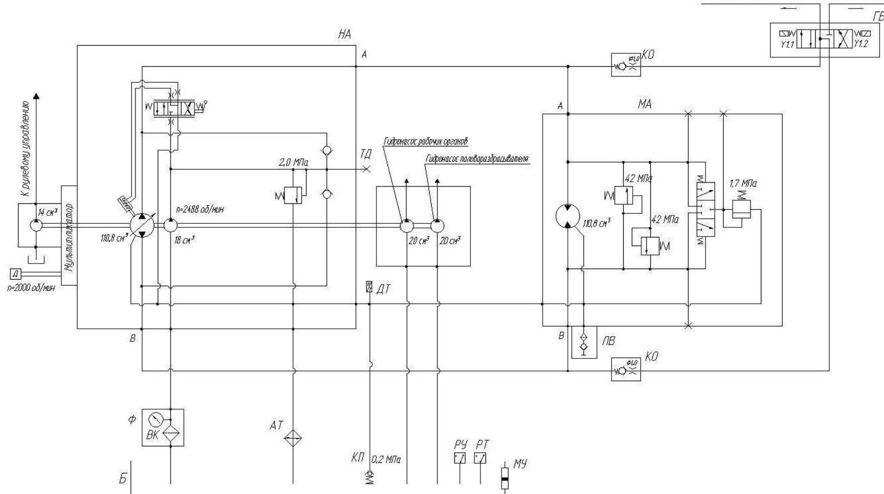
АТ – масляная секция радиатора; Б – бак масляный; ВК – вакуумметр 10; ГБ – гидроблок GB2-01; ДТ - датчик указателя температуры жидкости ДУТЖ-01; КО – клапан обратный; КП – гидроклапан обратный; МА – гидромотор аксиально – поршневой нерегулируемый; МУ – указатель уровня масла; НА – тандем насосов; ПВ – полумуфта внутренняя; РТ – датчик аварийной температуры жидкости ДАТЖ-04; РУ – датчик гидросигнализатор; ТД – соединение резьбовое с колпачком; Ф – фильтр
