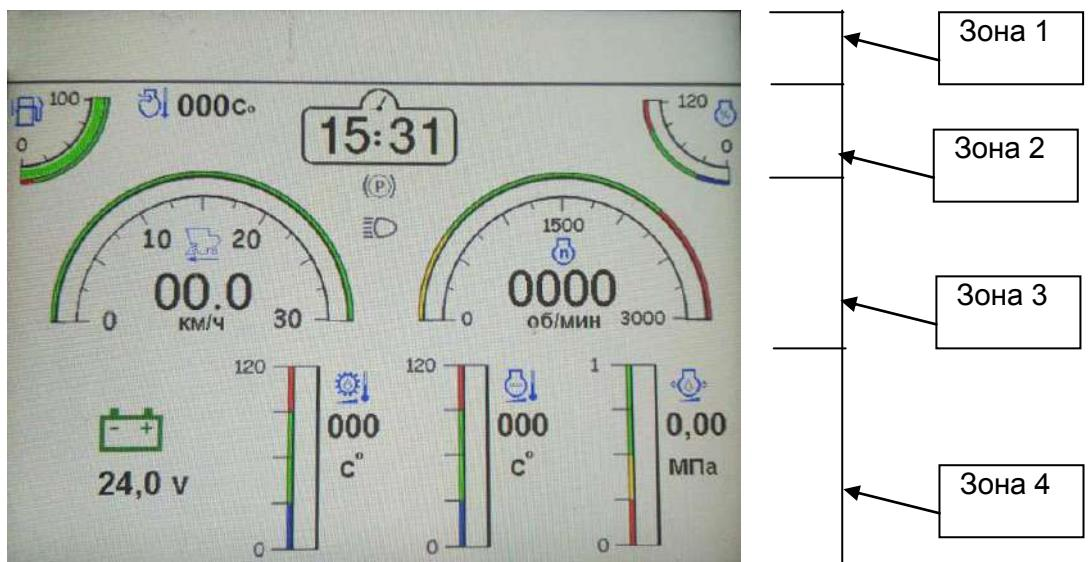
Рисунок Ж.4 – Экран транспортного режима
