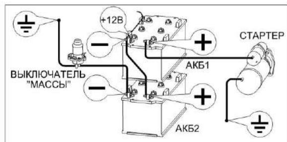
Рисунок 2.3 - Подключение аккумуляторных батарей
