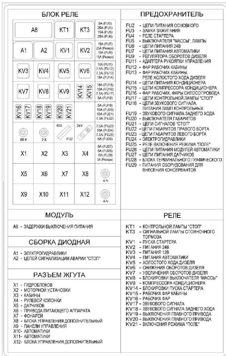
Рисунок 1.23 – Схема соединений шкафа распределительного
