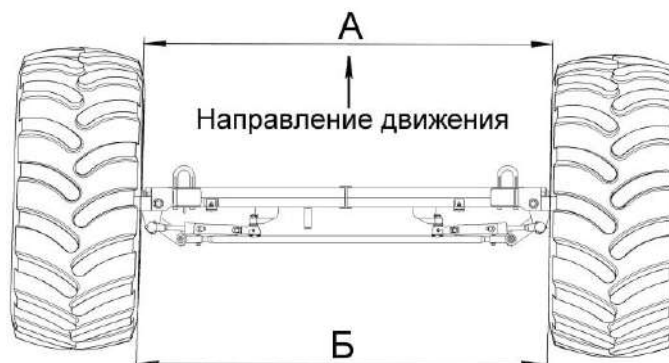
Рисунок 2.27 – Схема регулировки сходимости колес
