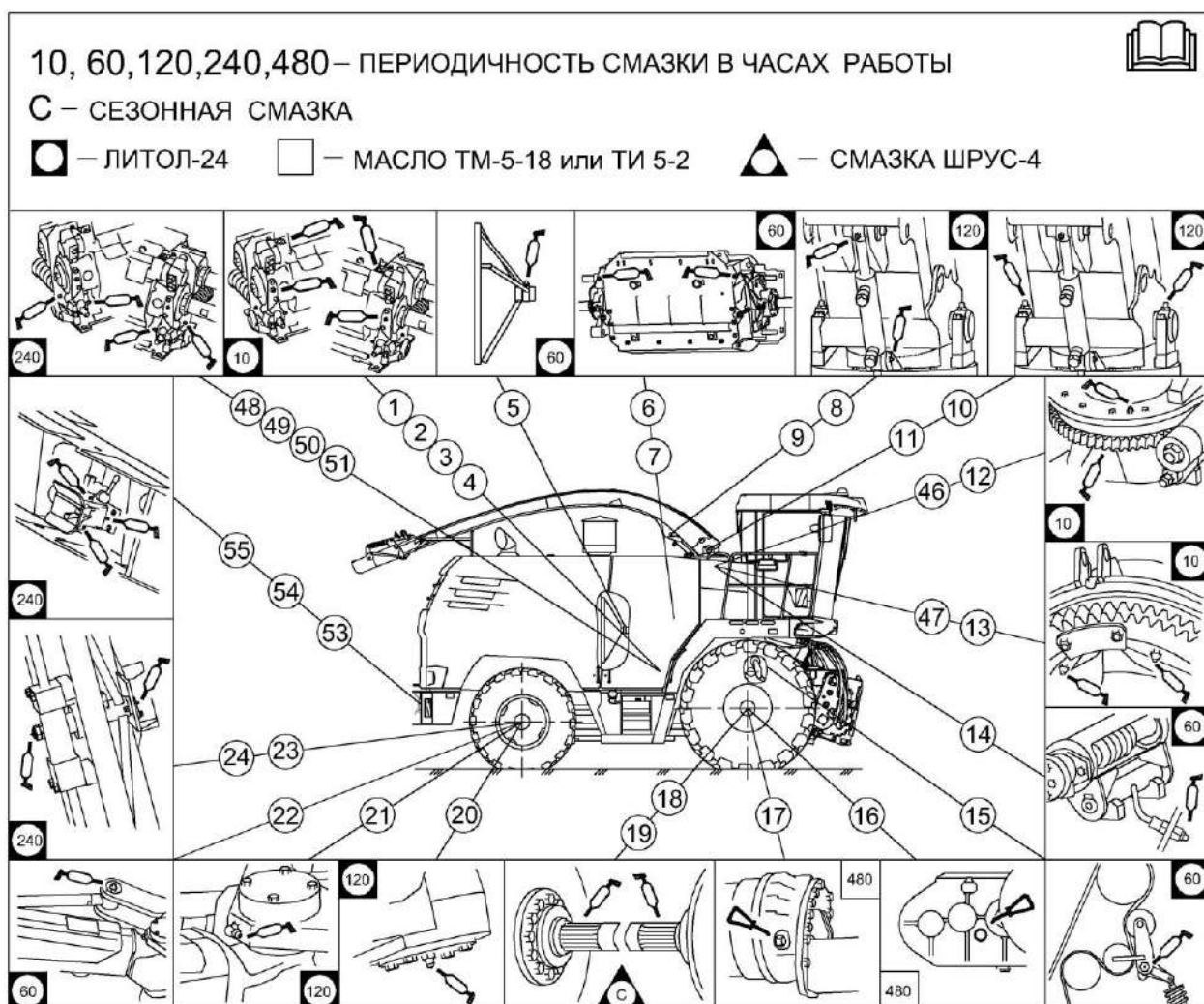
Рисунок 3.9 – Схема смазки комбайна (вид справа)
