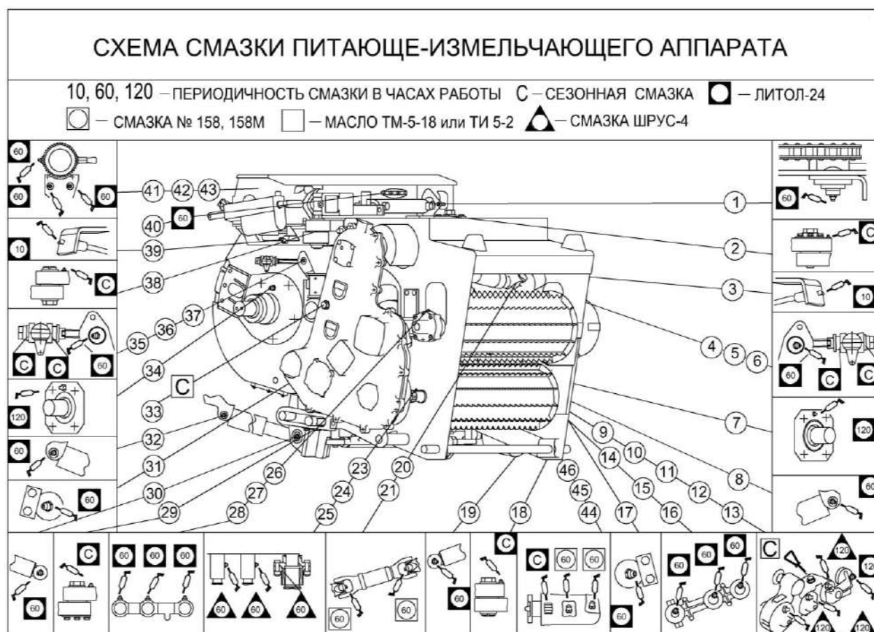
Рисунок 3.11 – Схема смазки питающе-измельчающего аппарата комбайна
