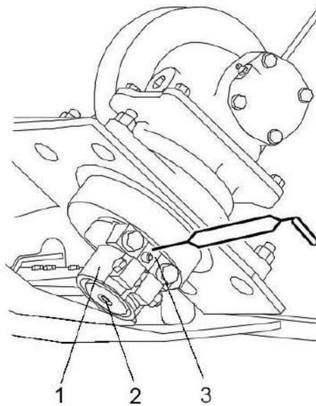
1 – головка ножа режущего аппарата; 2 – винт; 3 – подшипник
