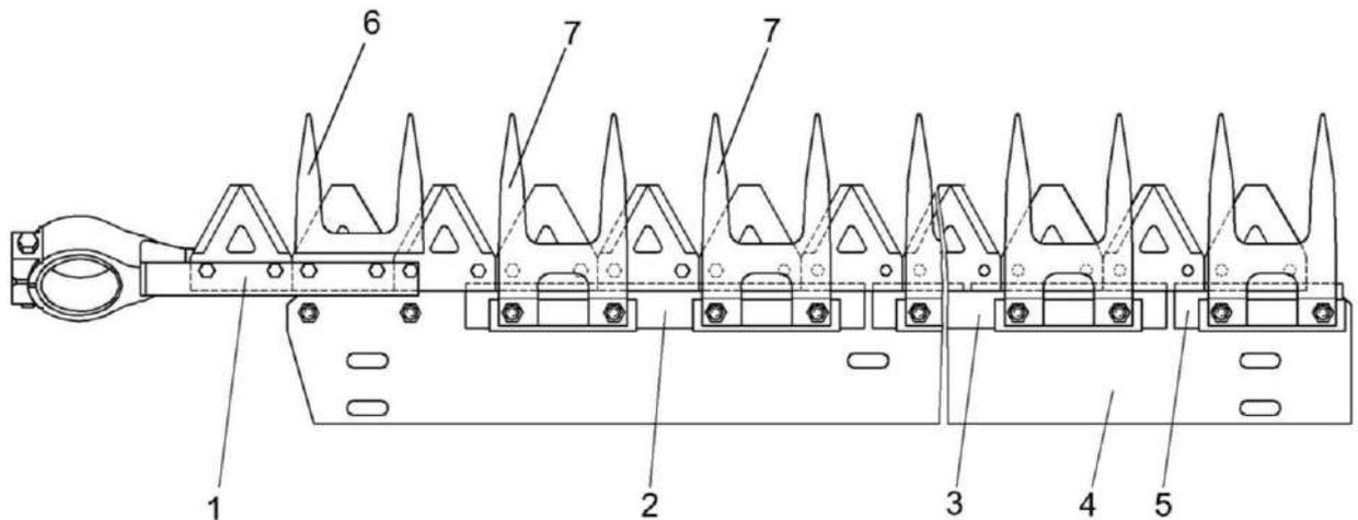
1 – нож; 2, 3, 5 – пластины трения; 4 – брус; 6 – палец направляющий сдвоенный; 7 – палец сдвоенный
