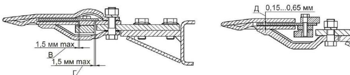
Рисунок 2.9 – Режущий аппарата жатки для трав
