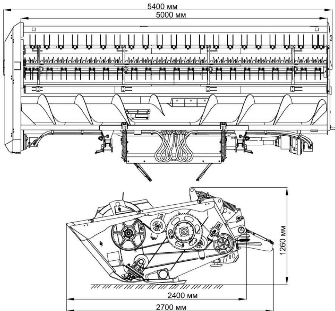
Рисунок 1.1 – Габаритные размеры жатки для трав
