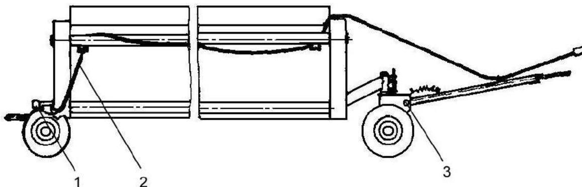
1 – задняя тележка; 2 – жгут проводов; 3 – передняя тележка
