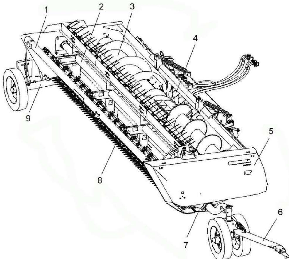
1 – рама; 2 – мотовило; 3 – шнек; 4 – аппарат плющильный; 5 – щиток; 6 – тележка транспортная передняя; 7 – башмак; 8 – аппарат режущий; 9 – тележка транспортная задняя
