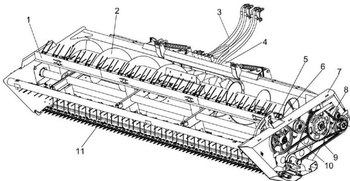
1 – мотовило; 2 – шнек; 3 – гидросистема; 4 – аппарат плющильный; 5 – ролик; 6 – дорожка направляющая; 7 – рама; 8 – цепная передача привода шнека; 9 – ременная передача привода режущего аппарата; 10 – ременная передача привода мотовила; 11 – режущий аппарат
