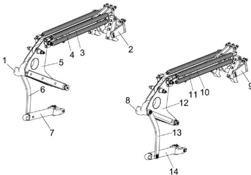
1 – крюк правый; 2, 9 – рычаги; 3, 10 – гидроцилиндры; 4, 11 – блоки пружин; 5 – рычаг верхний правый; 6, 13 – штанги; 7 – рычаг нижний правый; 8 – крюк левый; 12 – рычаг верхний левый; 14 – рычаг нижний левый
