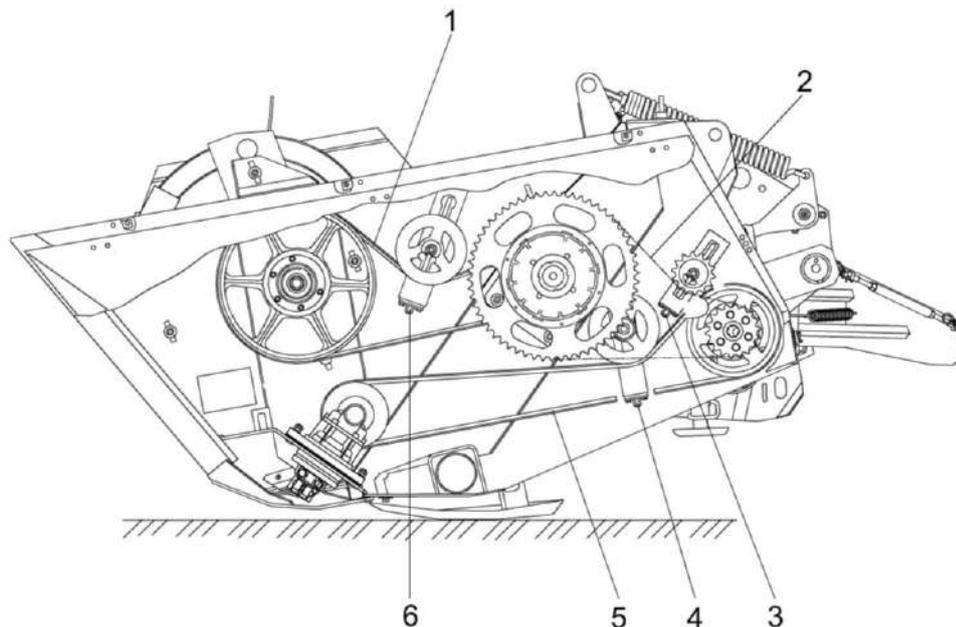
1 – ременная передача привода мотовила; 2 – цепная передача привода шнека;
