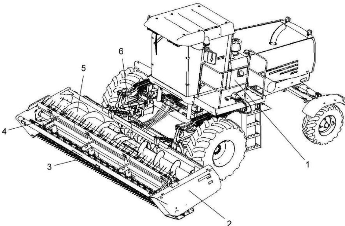
1 – косилка; 2 – жатка; 3 – режущий аппарат; 4 – мотовило; 5 – шнек;
