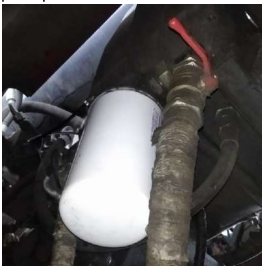
Рисунок 3.10 – Вид на перекрытый кран сливного фильтроэлемента
