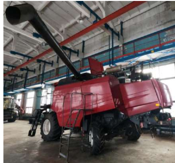
Рисунок 3.12 – Вид на трубу выгрузного шнека повернутую на угол не менее
