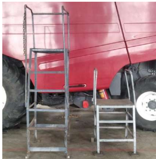
Рисунок 3.7 – Вид на лестницы с площадкой
