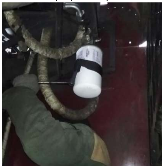
Рисунок 3.11 – Вид на сливной фильтроэлемент, демонтируемый при помощи ключа фильтра
