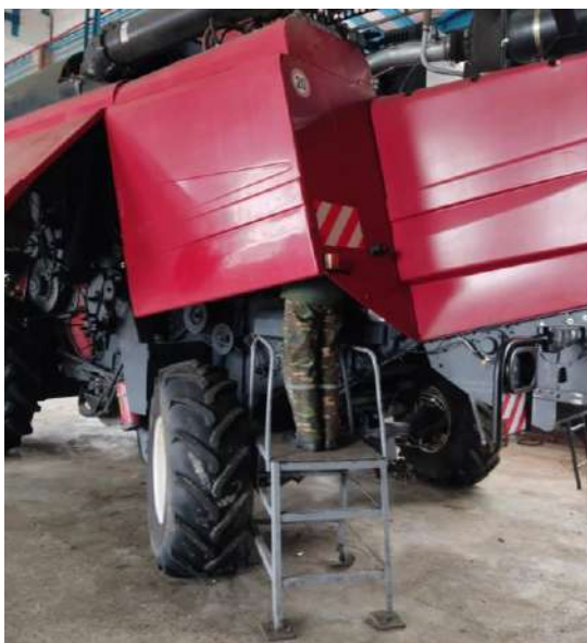
Рисунок 3.9 – Вид на лестничную площадку с оператором при замене сливного и напорного фильтроэлементов
