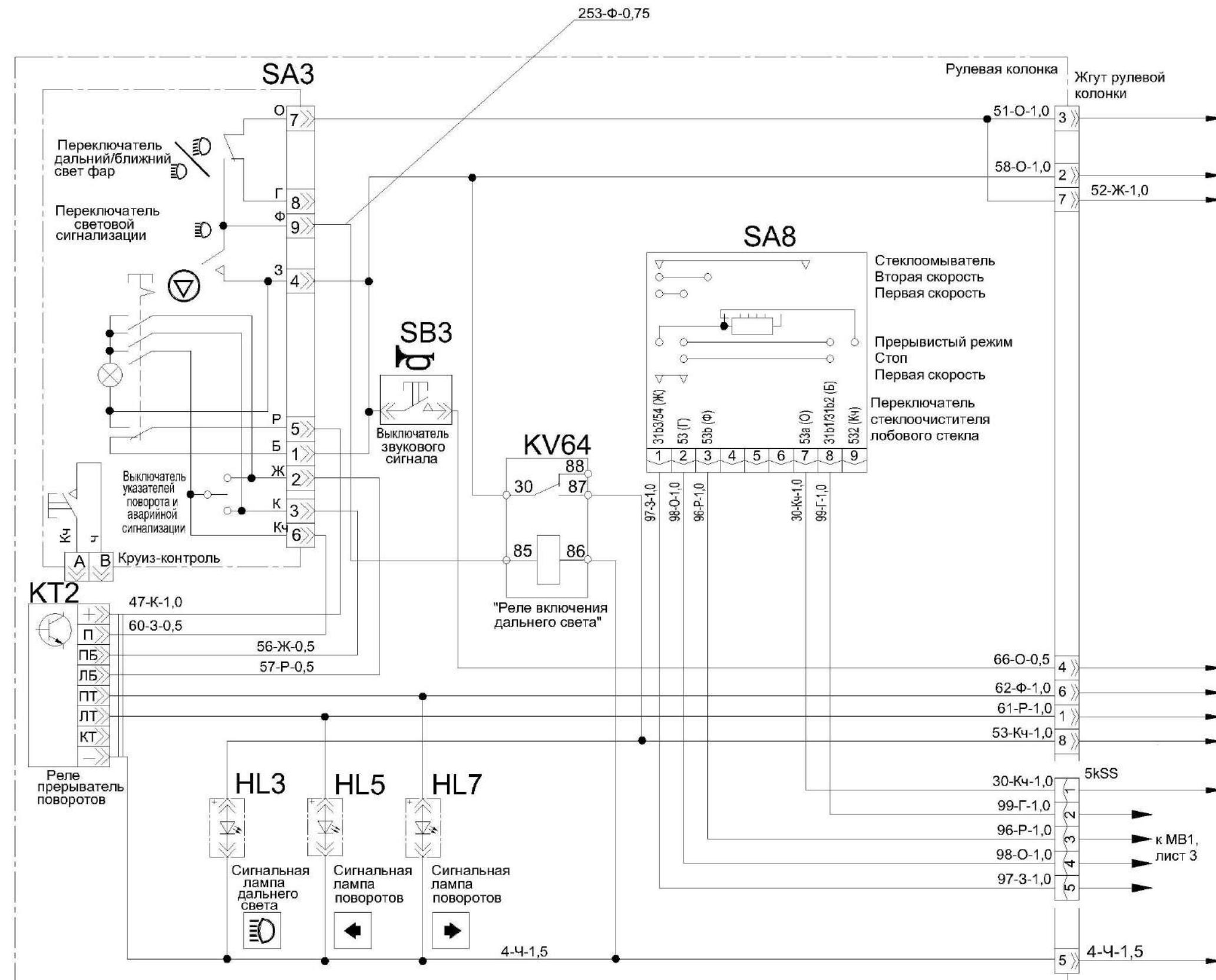
Рисунок Б.2 – Схема электрическая принципиальная комбайна (лист 2.1)
