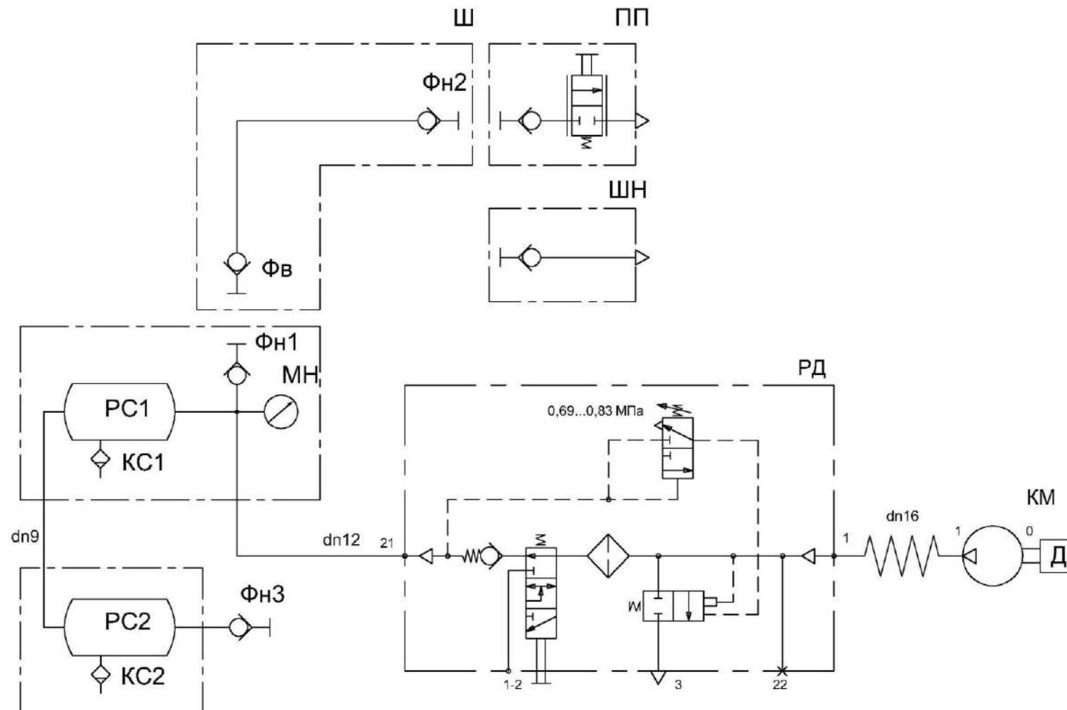
КМ - компрессор; КС1, КС2 – клапаны слива конденсата; МН – манометр; ПП – пневмопистолет обдувочный; РД – регулятор давления; РС1, РС2 – ресиверы; ФВ – фитинг; Фн1, Фн2, Фн3 – фитинги; Ш – шланг; ШН – шланг для накачивания шин
