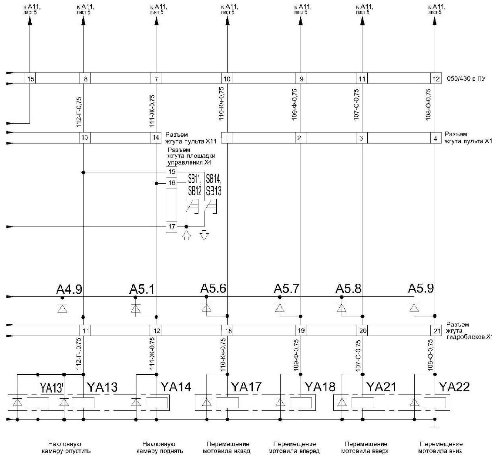
Таблица 1 - Включение электромагнитов гидроблоков ГБ1 и ГБ2
