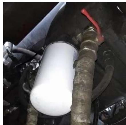
Рисунок 3.9 – Перекрытый кран сливного фильтроэлемента
