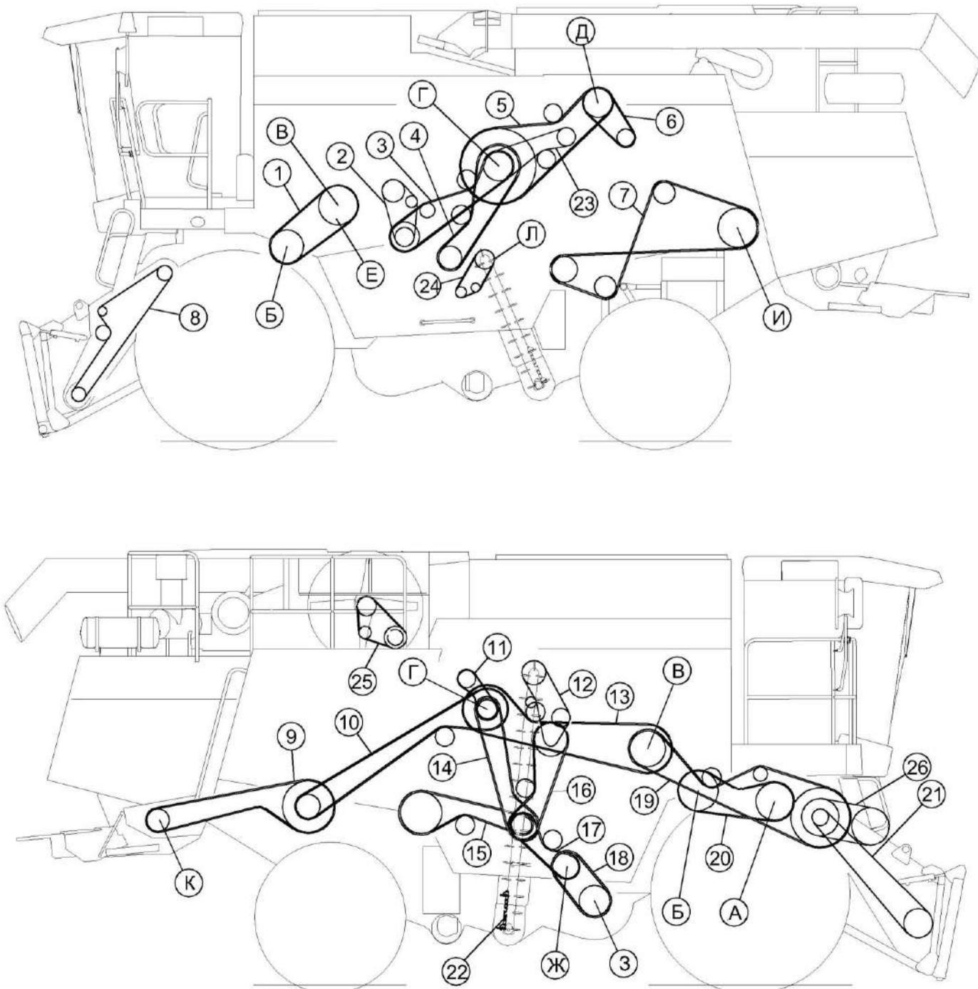
А – Барабан ускоряющий; Б – Барабан молотильный; В – Отбойный битер; Г – Главный привод; Д – Двигатель; Е – Вариатор МСУ; Ж – Вариатор очистки; З – Вентилятор; И – Соломотряс; К – Соломоизмельчитель; Л – Элеватор колосовой.
