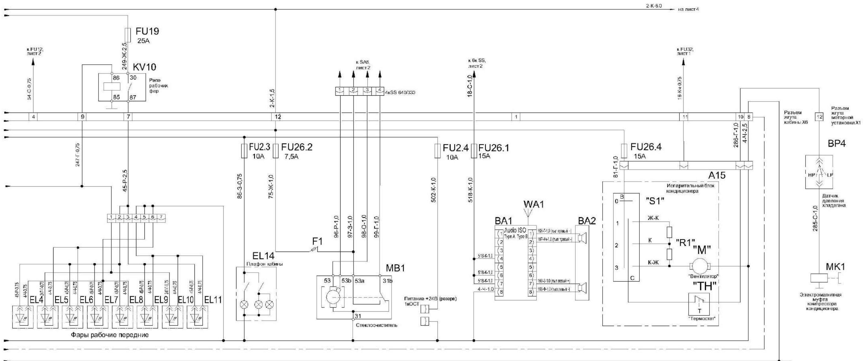
Рисунок Б.3 – Схема электрическая принципиальная комбайна (лист 3.2)
