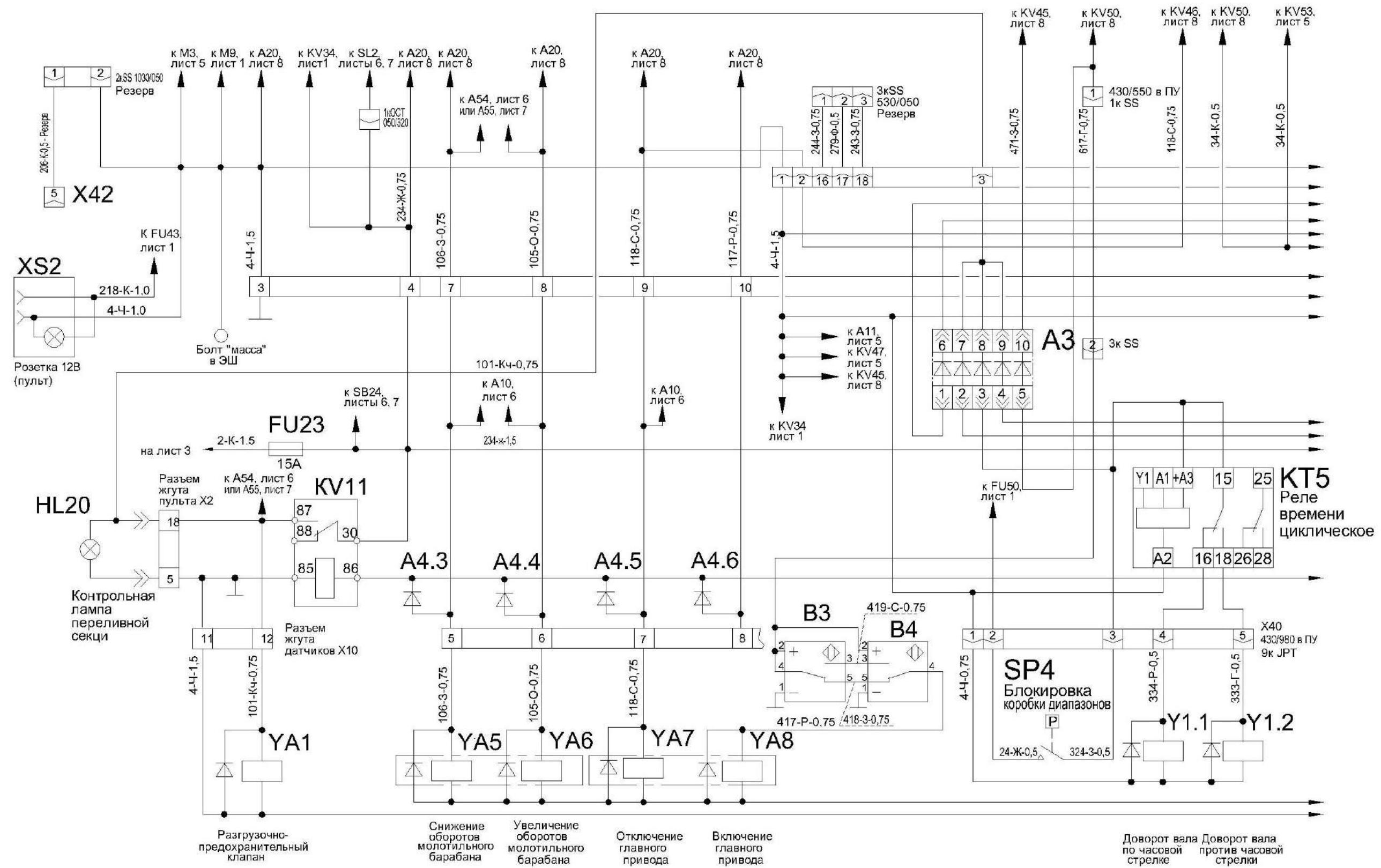
Рисунок Б.4 – Схема электрическая принципиальная комбайна (лист 4.1)
