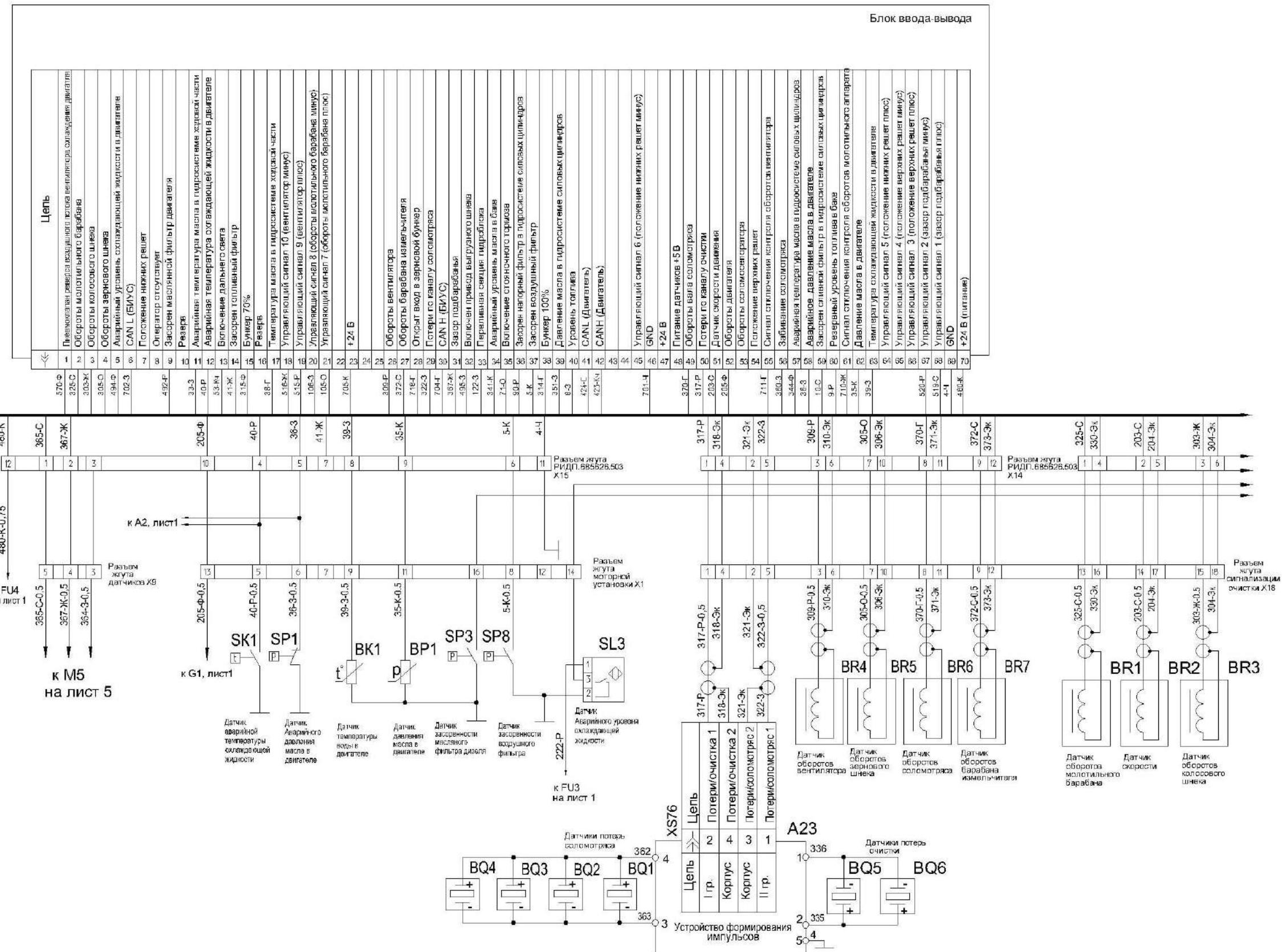
Рисунок Б.6 – Схема электрическая принципиальная комбайна (лист 6.1)
