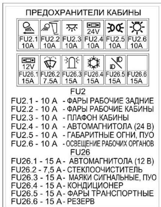
Рисунок 1.37 – Схема расположения предохранителей
