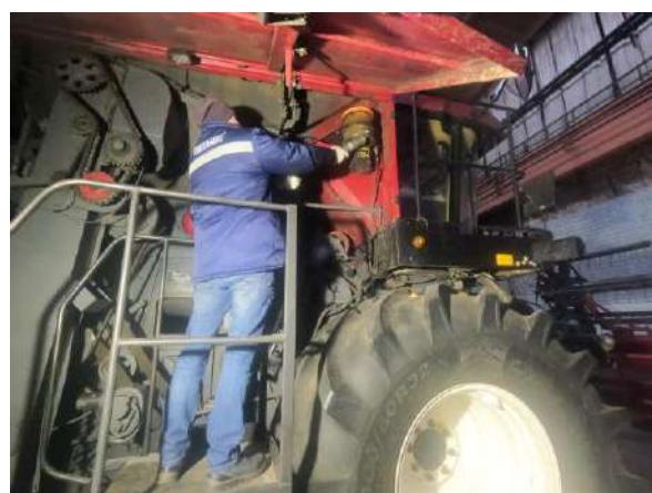
Рисунок 3.4 – Заправка насоса АЦСС
