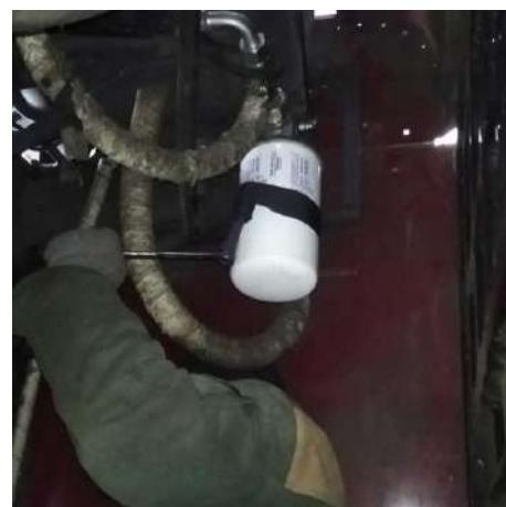
Рисунок 3.10 – Сливной фильтроэлемент, демонтируемый при помощи ключа фильтра
