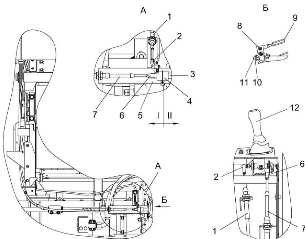
1, 7 - штоки тросов; 2, 6 - шарниры угловые; 3 - шток коробки диапазонов; 4 – поводок;
