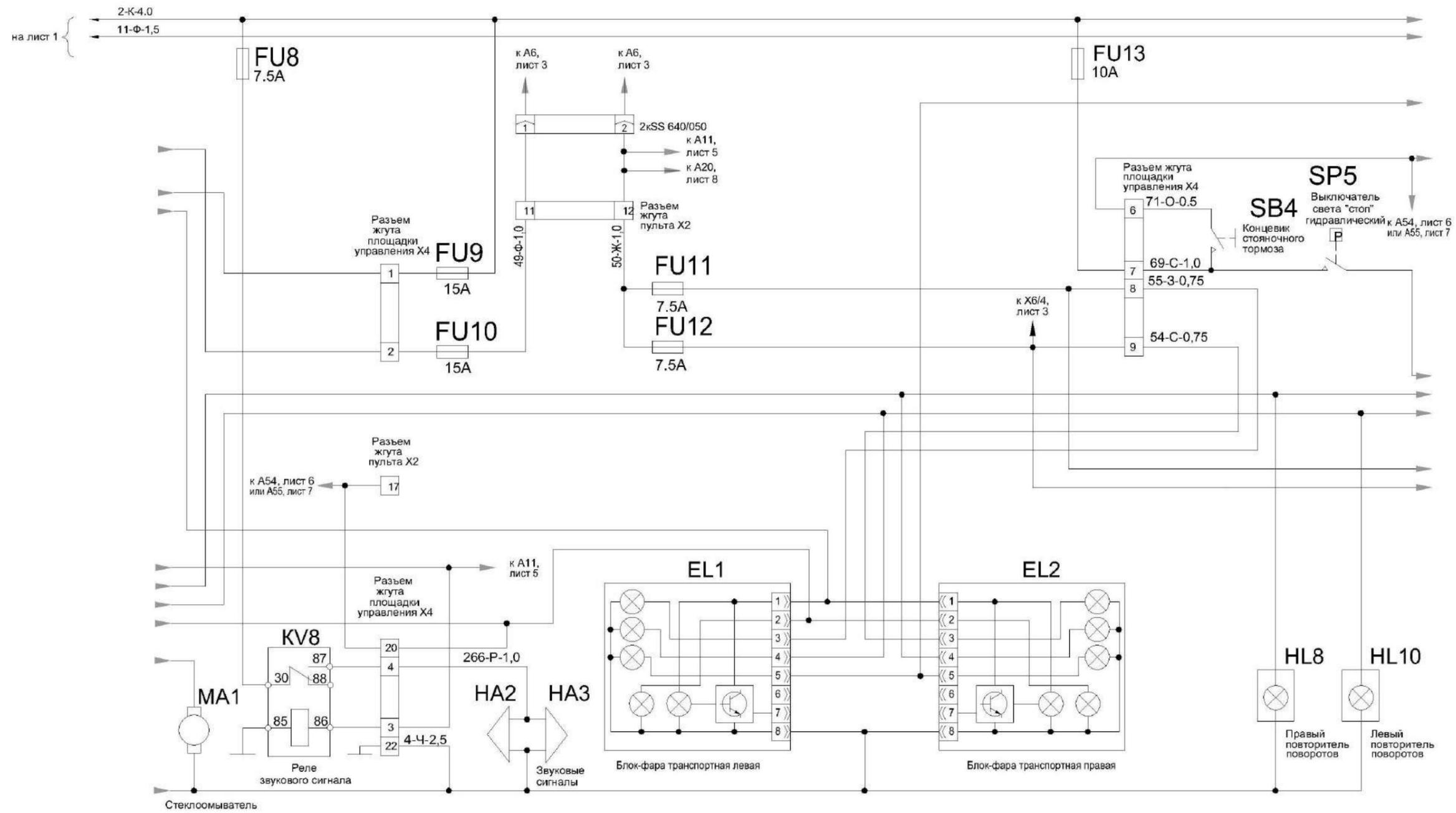
Рисунок Б.2 – Схема электрическая принципиальная комбайна (лист 2.2)
