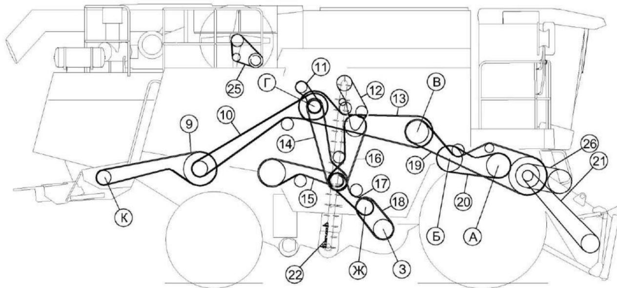
А – Барабан ускоряющий; Б – Барабан молотильный; В – Отбойный битер; Г – Главный привод; Д – Двигатель; Е – Вариатор МСУ; Ж – Вариатор очистки; З – Вентилятор; И – Соломотряс; К – Соломоизмельчитель; Л – Элеватор колосовой.
