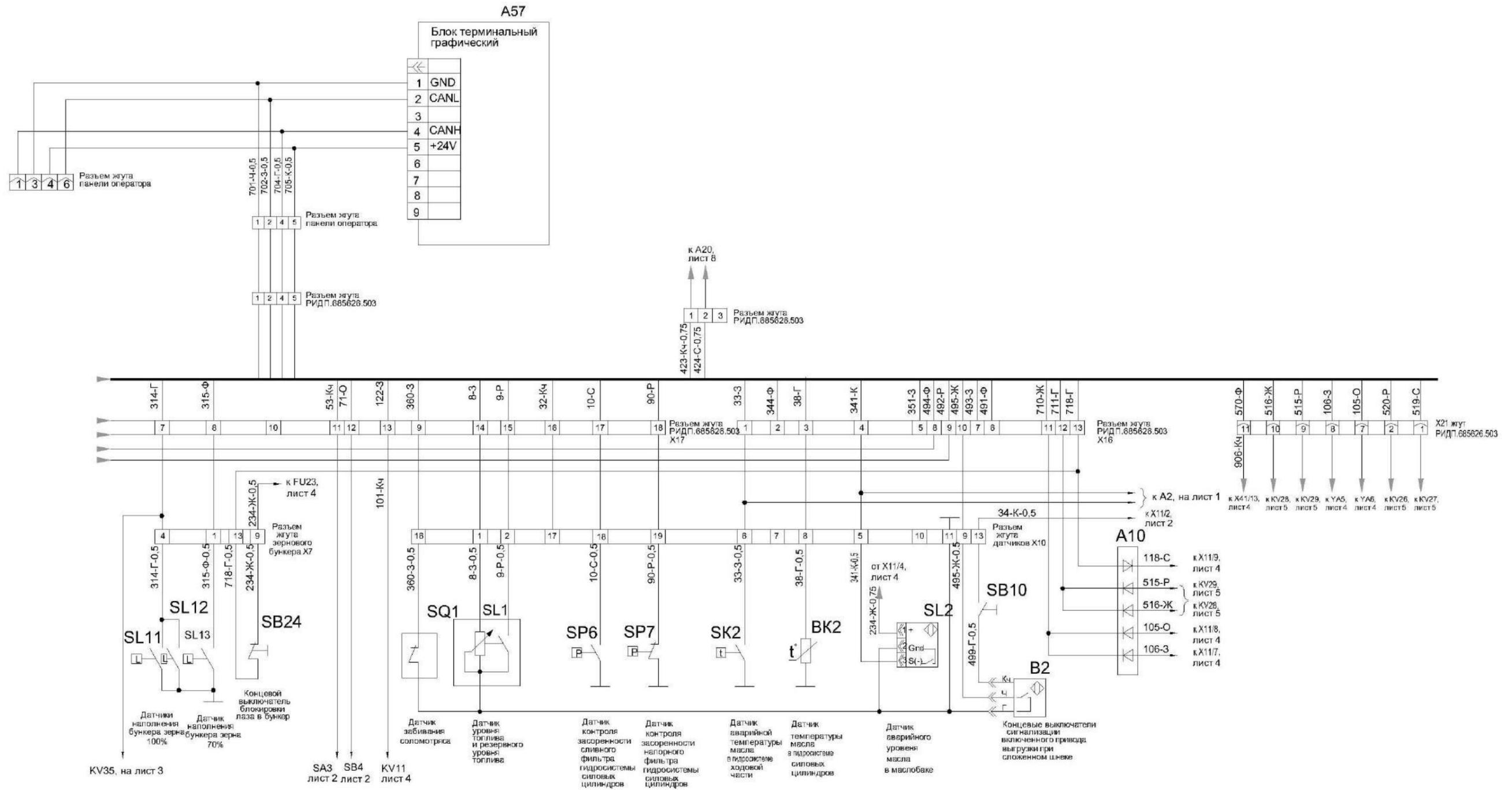
Рисунок Б.6 – Схема электрическая принципиальная комбайна (лист 6.2)
