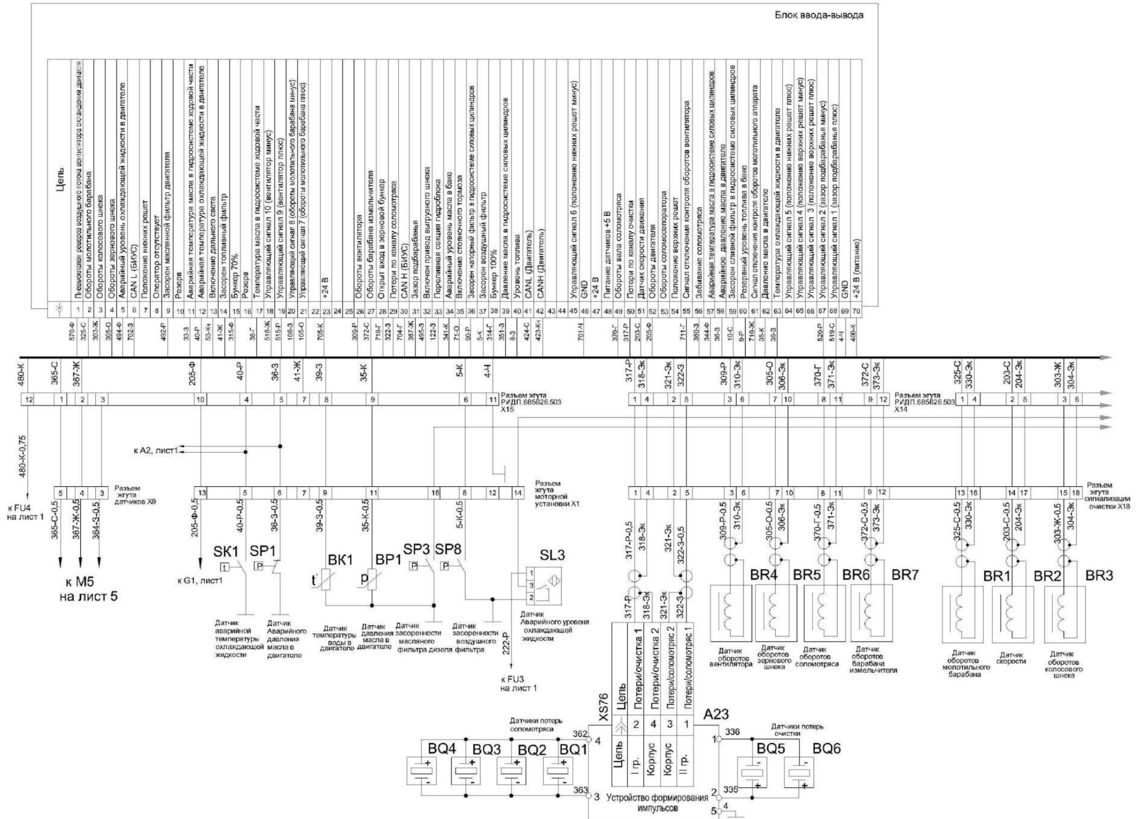
Рисунок Б.6 – Схема электрическая принципиальная комбайна (лист 6.1)
