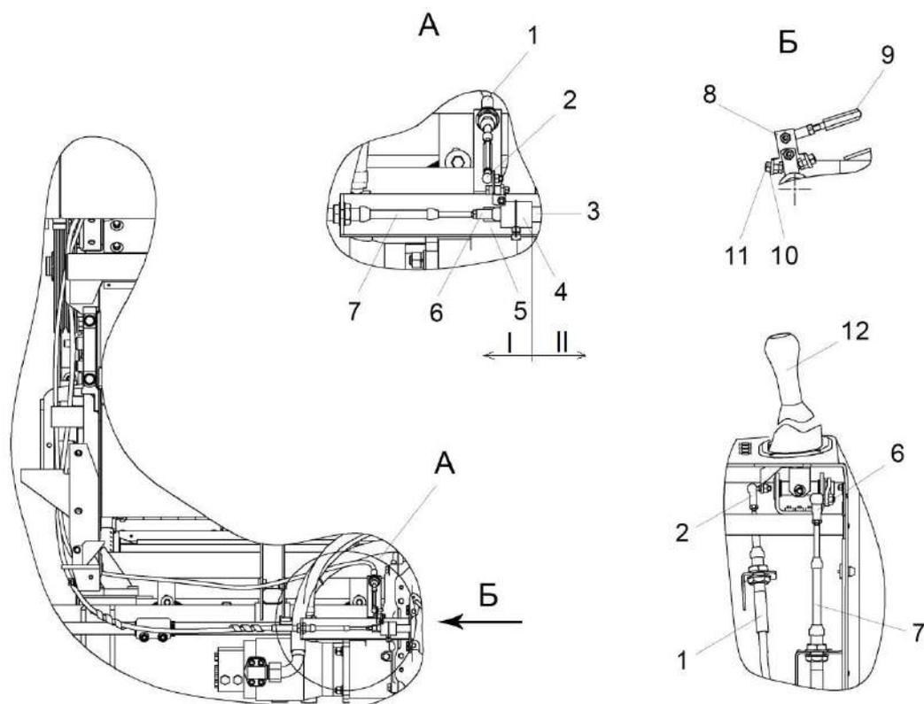
1, 7 - штоки тросов; 2, 6 - шарниры угловые; 3 - шток коробки диапазонов; 4 - поводок; 5 - кронштейн; 8 - кулиса; 9 - тяга; 10 - болт; 11 - гайка; 12 - рычаг
