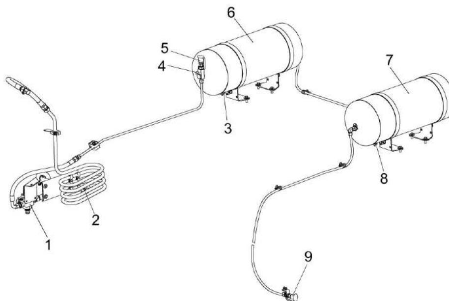
1 – регулятор давления; 2 – спиральный охладитель; 3, 8 – клапаны слива конденсата; 4 – манометр; 5, 9 – пневмовыводы; 6, 7 – ресиверы
