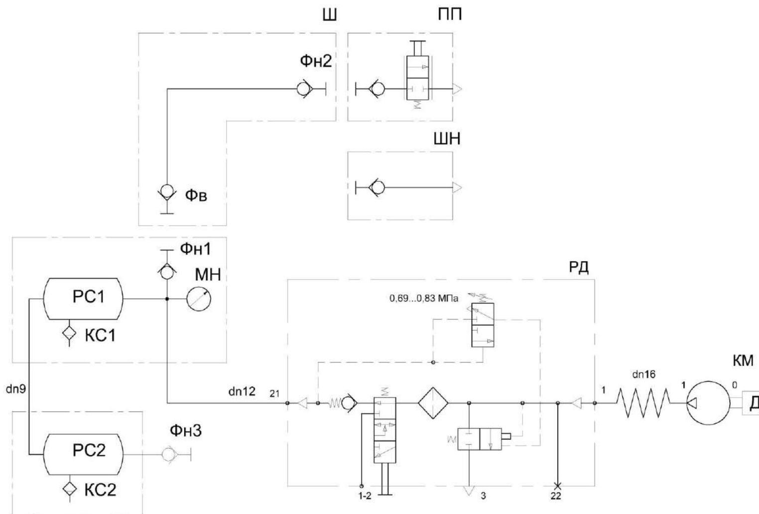
КМ - компрессор; КС1, КС2 – клапаны слива конденсата; МН – манометр; ПП – пневмопистолет обдучочный; РД – регулятор давления; РС1, РС2 – ресиверы; Фв – фитинг; Фн1, Фн2, Фн1 – фитинги; Ш – шланг; ШН – шланг для накачивания шин
