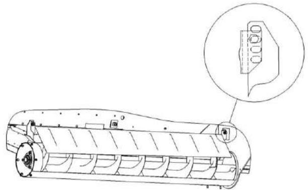
Рисунок 2.13 – Регулировка ограждения над горизонтальным шнеком бункера
