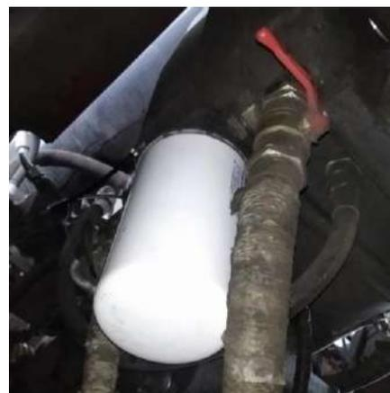
Рисунок 3.9 – Перекрытый кран сливного фильтроэлемента
