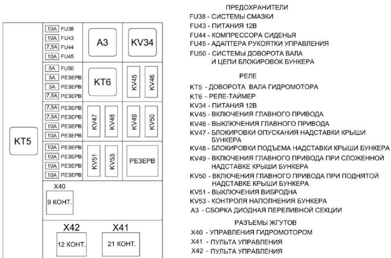
Рисунок 1.32 – Реле и предохранители пульта управления
