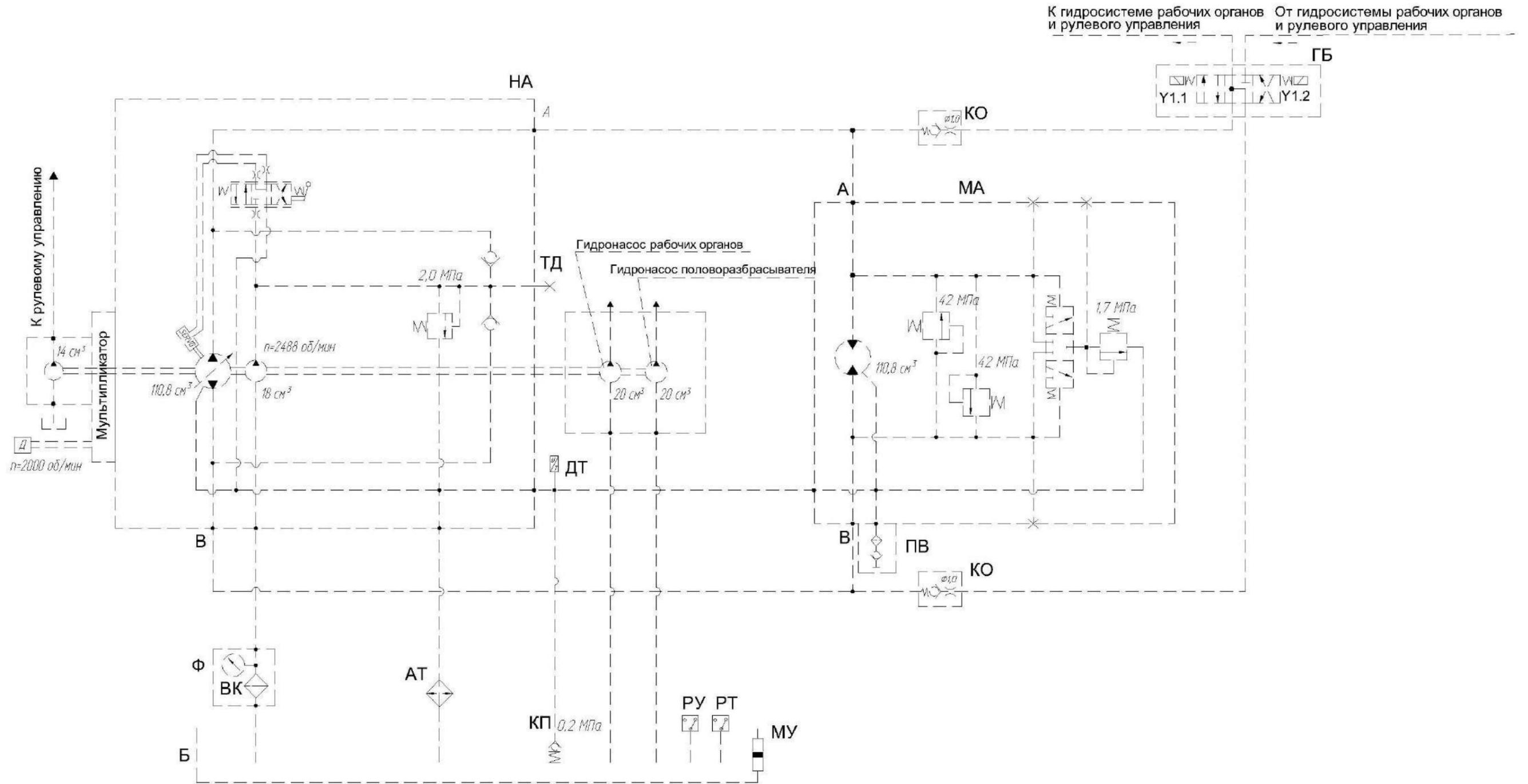
АТ – масляная секция радиатора; Б – бак масляный; ВК – вакуумметр; ГБ – гидроблок; ДТ - датчик указателя температуры жидкости ДУТЖ-01; КО – клапан обратный; КП – гидроклапан обратный; МА – гидромотор аксиально – поршневой нерегулируемый; МУ – указатель уровня масла; НА – тандем насосов; ПВ – полумуфта внутренняя; РТ – датчик аварийной температуры жидкости ДАТЖ-04; РУ – датчик гидросигнализатор; ТД – соединение резьбовое с колпачком; Ф – фильтр
