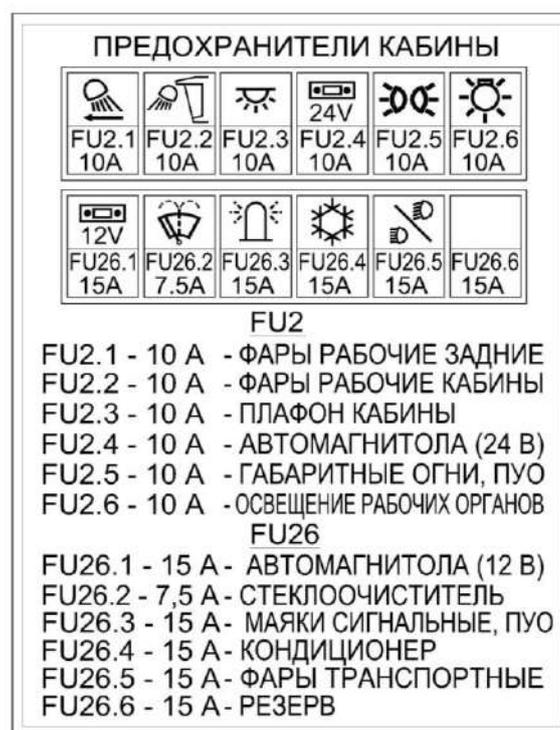
Рисунок 1.37 – Схема расположения предохранителей
