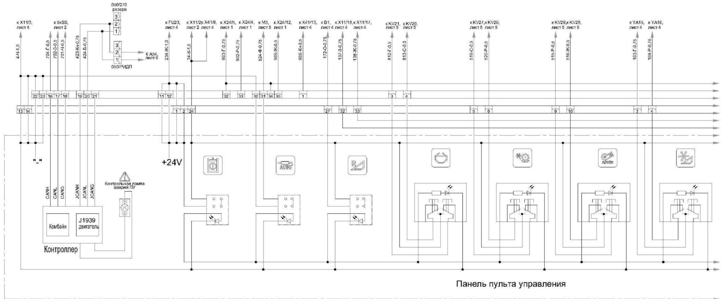
Рисунок Б.7 – Схема электрическая принципиальная комбайна (лист 8.1)
