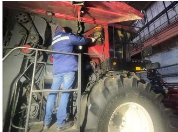
Рисунок 3.4 – Заправка насоса АЦСС
