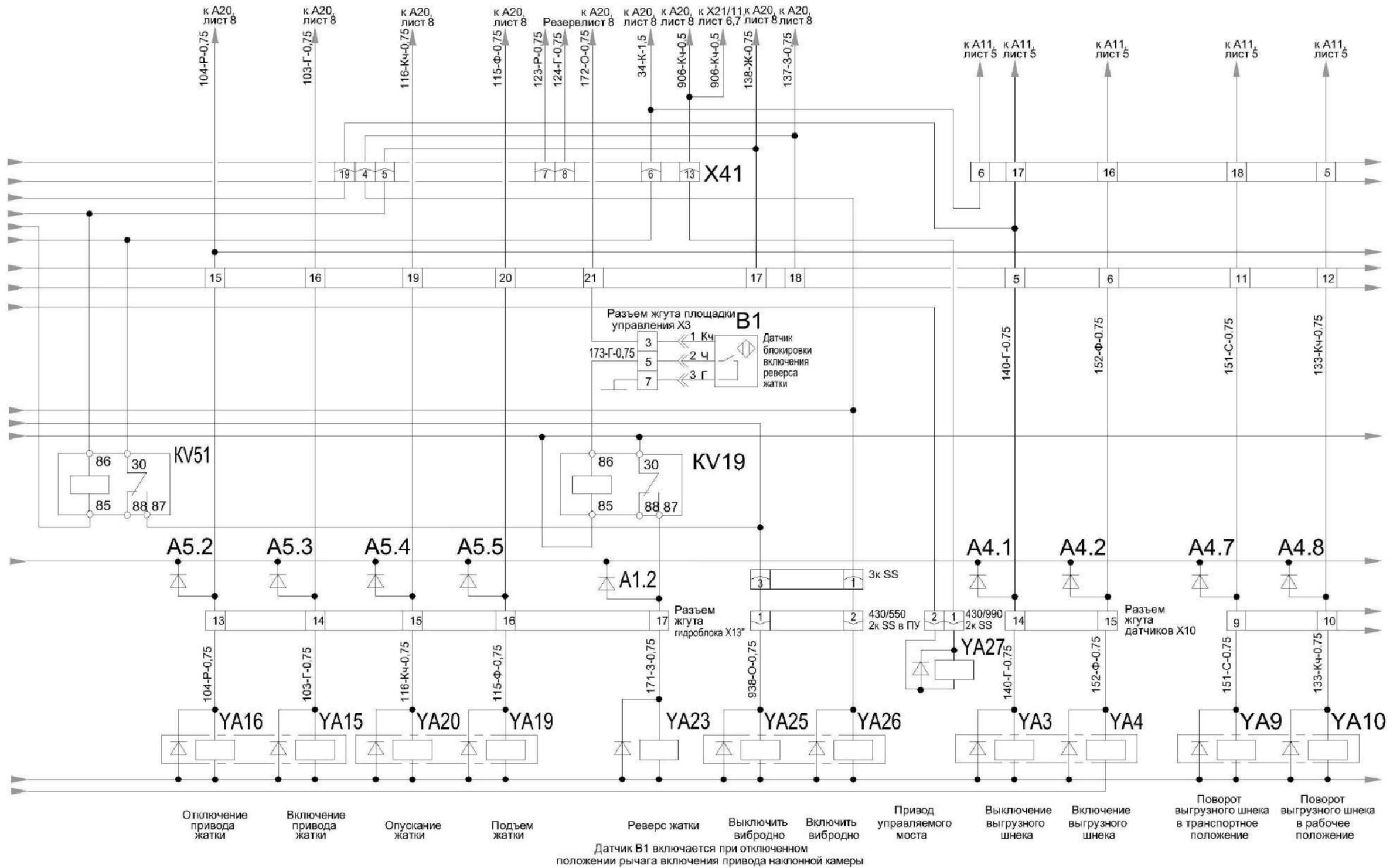
Рисунок Б.4 – Схема электрическая принципиальная комбайна (лист 4.2)
