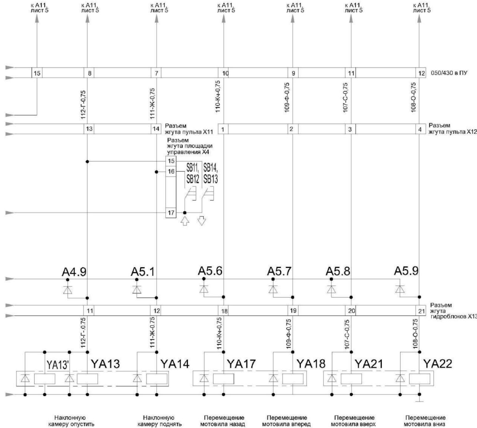
Включение электромагнитов гидроблоков ГБ1 и ГБ2
