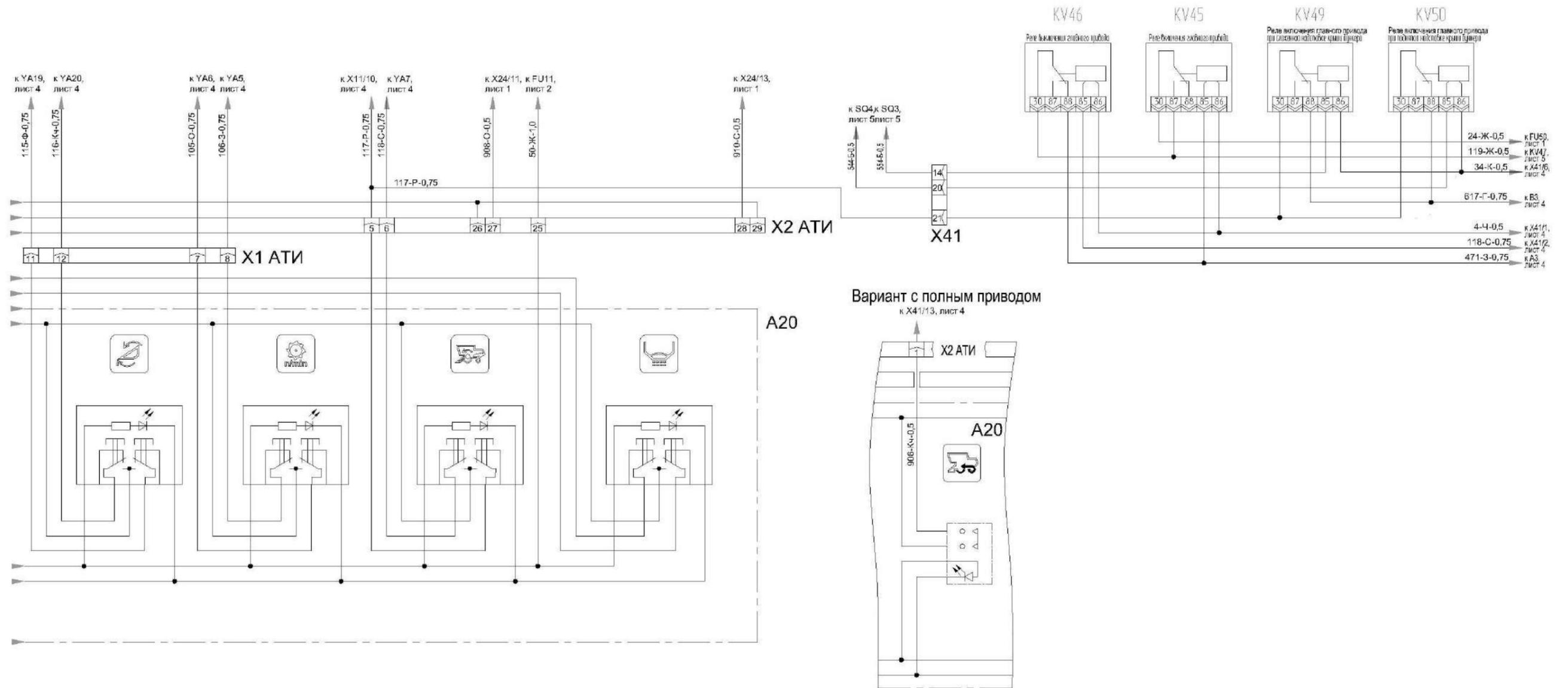
Рисунок Б.8 – Схема электрическая принципиальная комбайна (лист 8.2)
