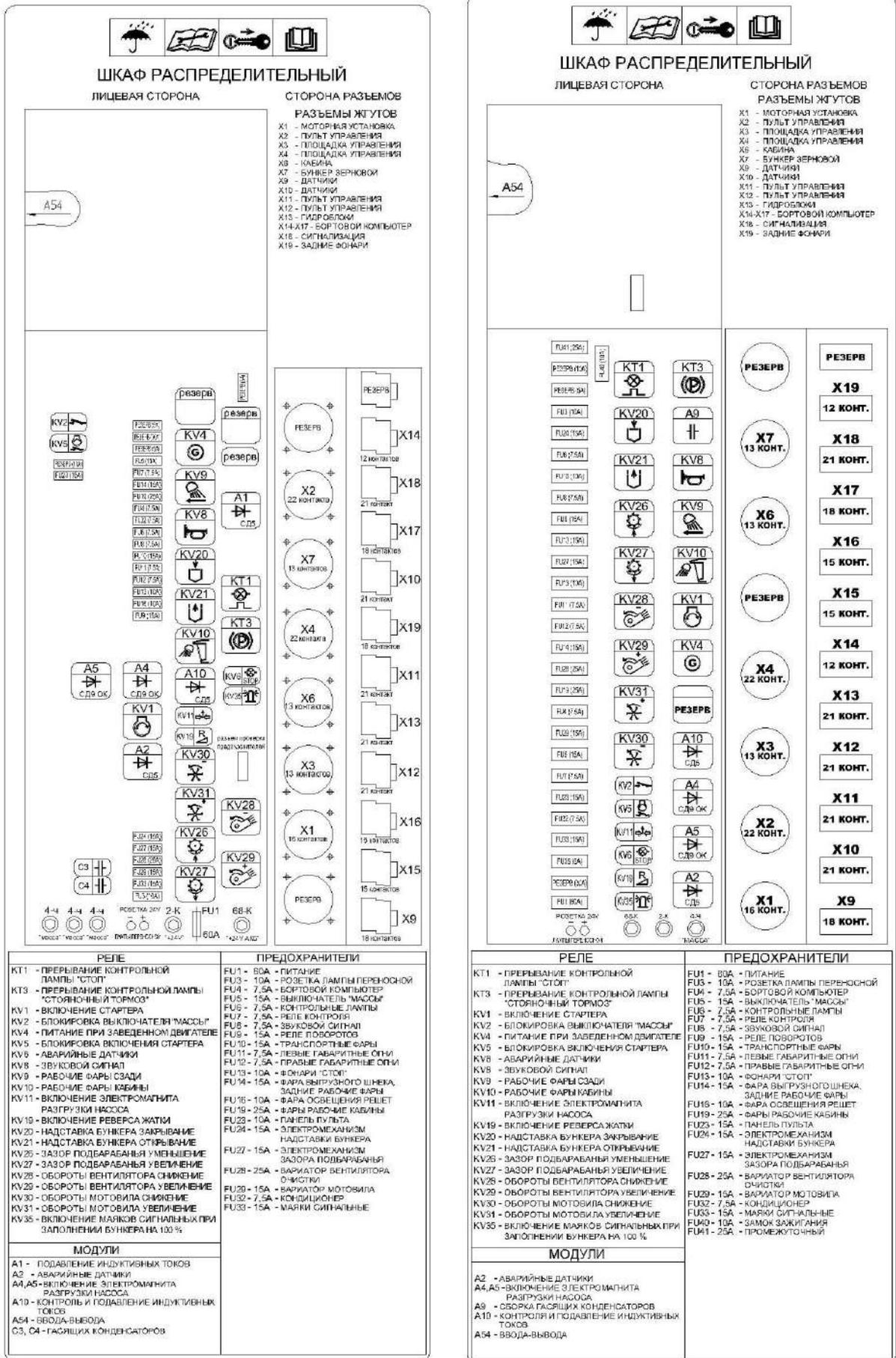
Рисунок 1.23 – Схема соединений шкафа распределительного
