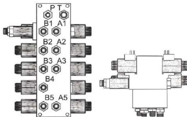
Рисунок 1.23 - Гидроблок пятисекционный
