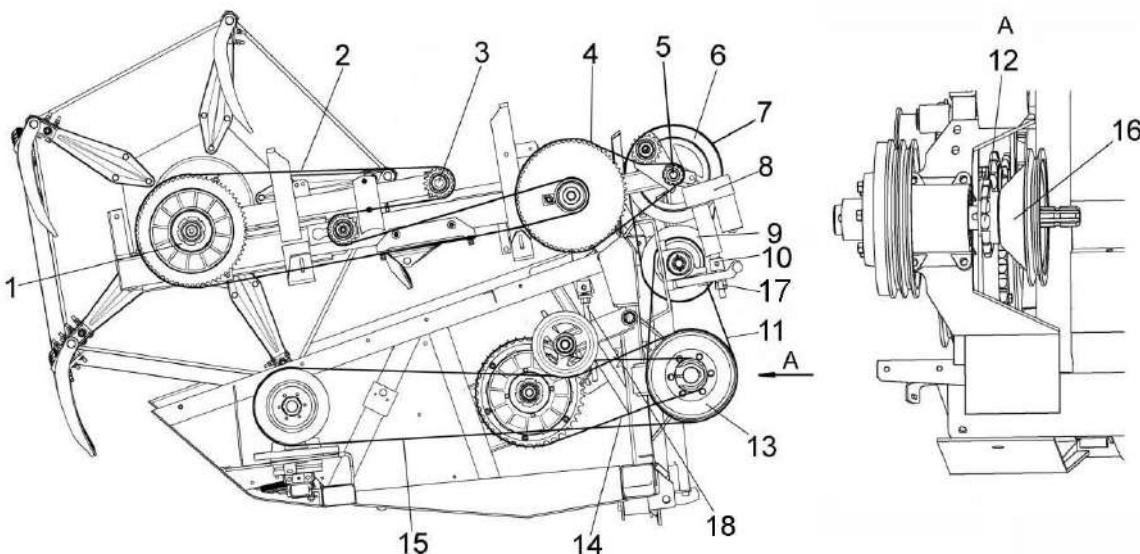
1 – муфта фрикционная; 2, 4, 14 – цепные передачи; 3, 5 – звездочки; 6, 13, 16 - шкивы; 7, 11, 15 – ременные передачи; 8 – исполнительный электромеханизм; 9 - вариатор; 10 – скоба; 12 – звездочка контрпривода; 17 – гайка; 18 - стяжка
