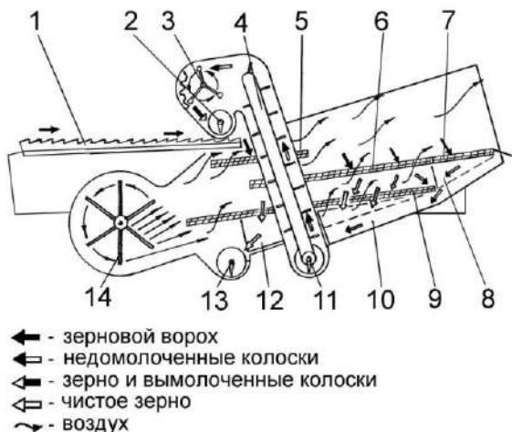
1 – стрясная доска; 2 – шnek распределительный; 3 – устройство домолачивающее; 4 – элеватор колосовой; 5 – дополнительное решето; 6 – решето верхнее; 7 - удлинитель верхнего решета; 8 - поддон удлинителя; 9 – решето нижнее; 10 – поддон колосовой; 11 – шnek колосовой; 12 – поддон зерновой; 13 – шnek зерновой; 14 – вентилятор
