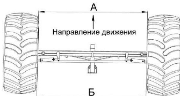
Рисунок 2.25 - Регулировка сходимости колес
