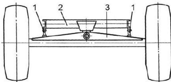
1 – болты; 2 – труба рамы; 3 – балка моста управляемых колес
