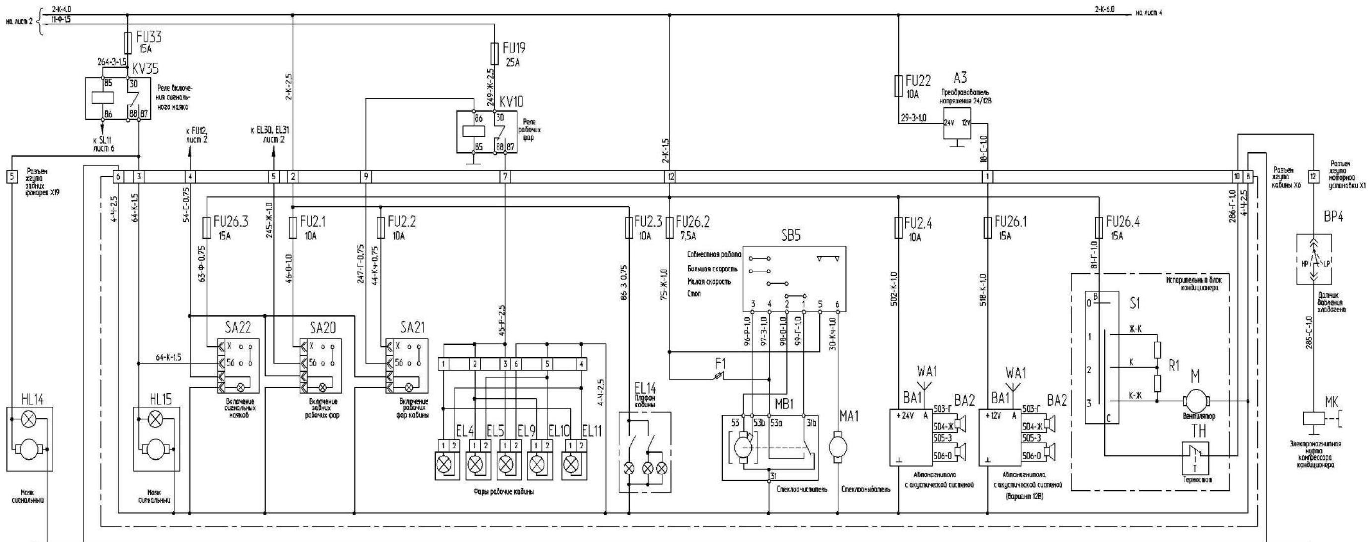
Рисунок Б.3 – Схема электрическая принципиальная комбайна (лист 3)
