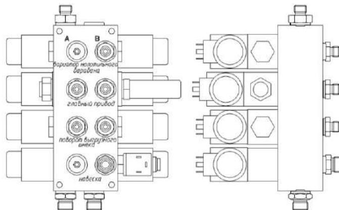
Рисунок 1.22 – Гидроблок четырехсекционный
