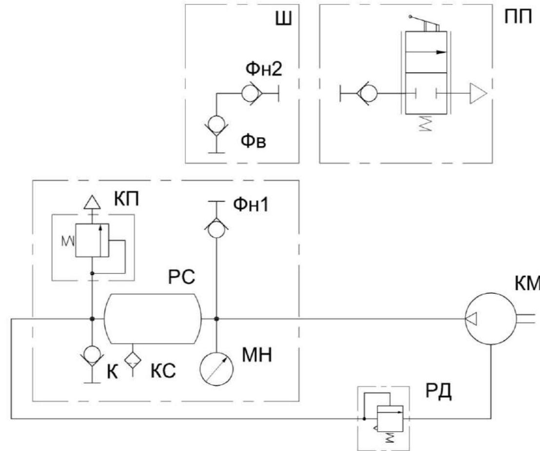
КМ – компрессор; РС – ресивер; К – клапан; КП – клапан предохранительный; КС – кран слива конденсата; МН – манометр; Фн1 – фитинг; Ш – шланг; ПП – пневмопистолет обдувочный; Фв – фитинг; Фн2 – фитинг; РД – регулятор давления
