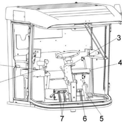
1 – рукоятка управления скоростью движения; 2 – пульт управления; 3 – рулевая колонка; 4 - рычаг переключения передач; 5 - рукоятка стояночного тормоза; 6 – педаль блокировки короб передач; 7 - тормозные педали
