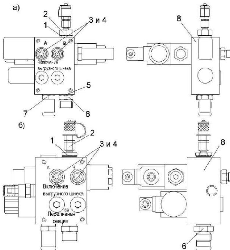
а) гидроблок односекционный;
