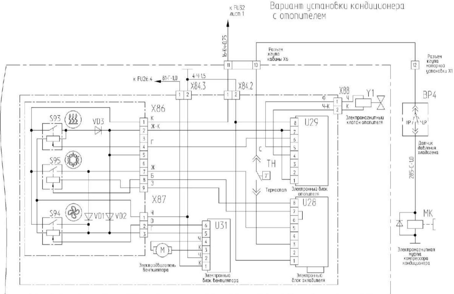
Рисунок Б.3а – Схема электрическая принципиальная комбайна (лист 3)
