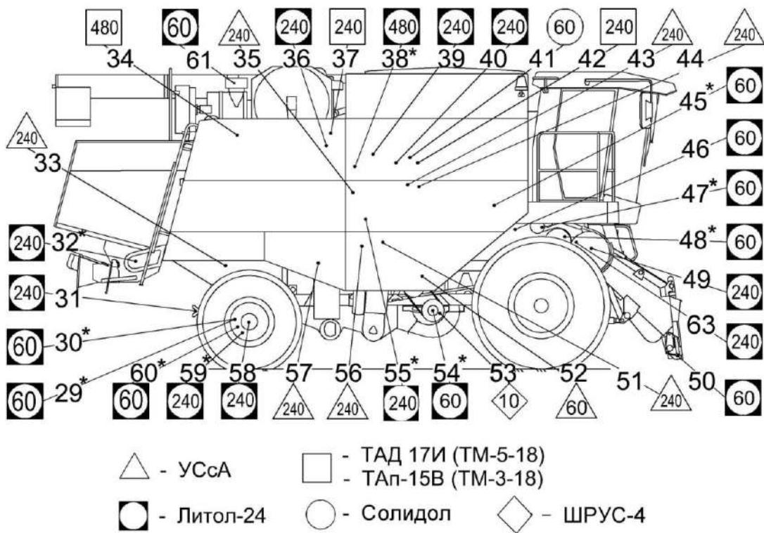
Рисунок 3.2 – Смазка молотилки (вид справа)
