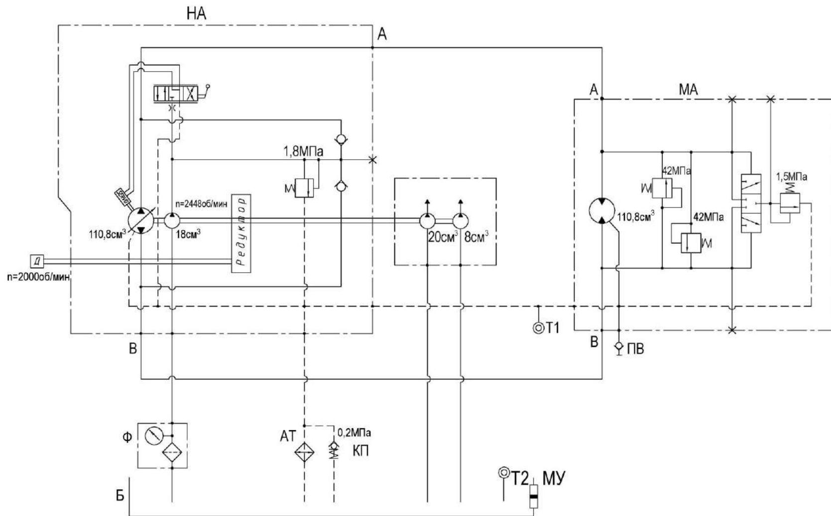
АТ – масляная секция радиатора; Б – бак масляный; КП – клапан обратный; МА – гидромотор аксиально - поршневой; НА – насос аксиально - поршневой; ПВ – полумуфта внутренняя; Т1 – датчик; Т2 - датчик сигнализатора температуры; МУ – указатель уровня масла; Ф – фильтр
