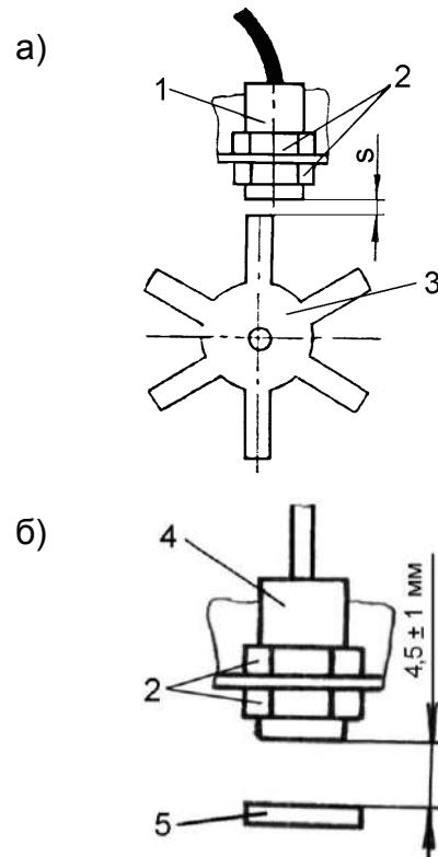
1 – датчик ПРП-1М; 2 – регулировочные гайки; 3 – звездочка; 4 – датчик; 5 – пластина
