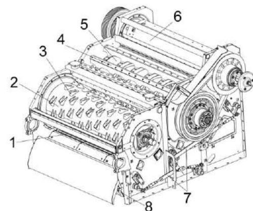
1 – подбарабанье; 2 – барабан ускоряющий; 3 – колпак; 4 – бич; 5 – барабан молотильный; 6 – отбойный битер; 7 – подвески подбарабанья; 8 – камнеуловитель
