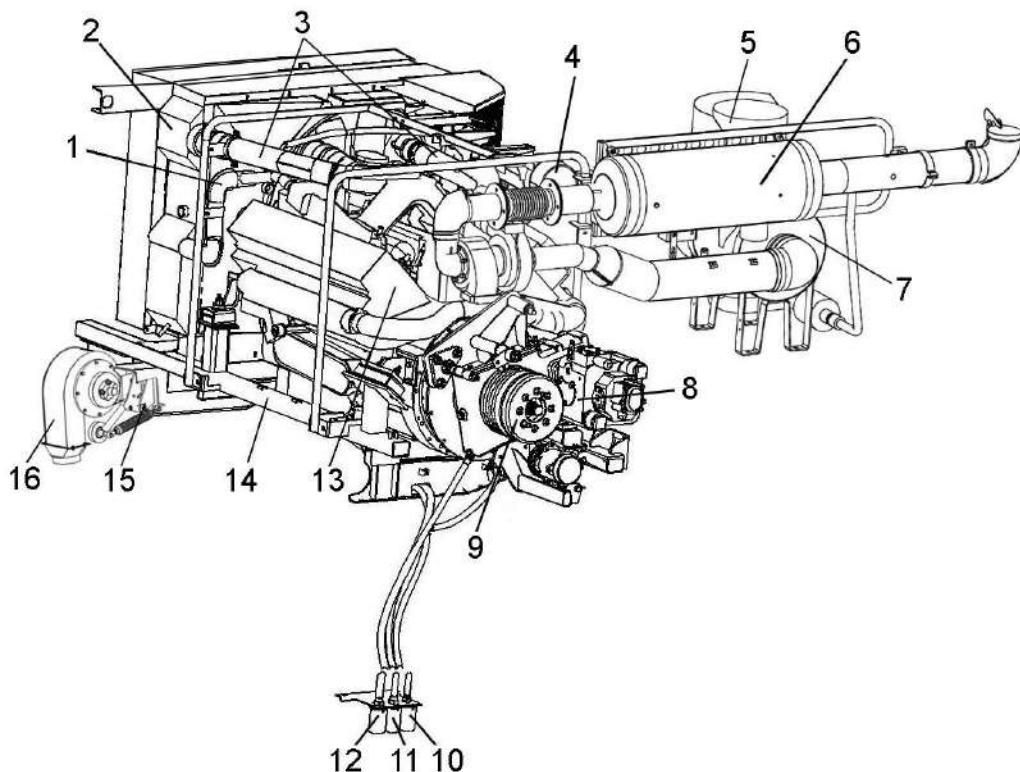
1 – труба водяная верхняя; 2 – радиатор; 3 – трубы воздушные; 4 – бачок расширительный; 5 - воздухозаборник врачающийся; 6 – глушитель; 7 –воздухозаборник; 8 – установка гидронасосов; 9 – главный привод; 10 – сливной рукав охлаждающей жидкости; 11 – сливной рукав масла из редуктора; 12 – сливной рукав масла из картера двигателя; 13 – двигатель; 14 – рама подмоторная; 15 – устройство натяжное; 16 – вентилятор
