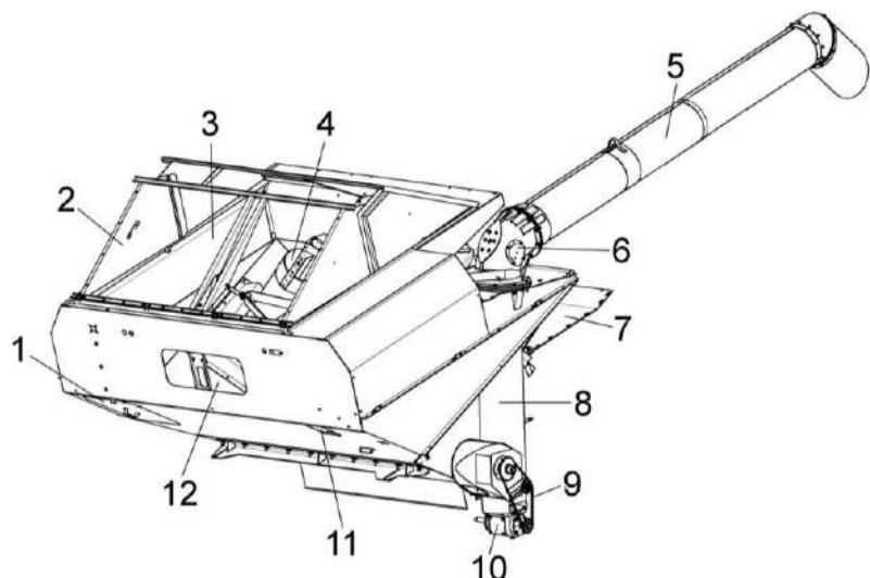
1 – крышка; 2 - крыша бункера; 3 - бункер; 4 – шнек загрузной; 5 - шнек поворотный выгрузной; 6 - отвод с редуктором; 7 – настил; 8 – шнек наклонный выгрузной; 9 – цепная передача привода шнека горизонтального; 10 – редуктор; 11 - окно пробоотборника; 12 - смотровое окно
