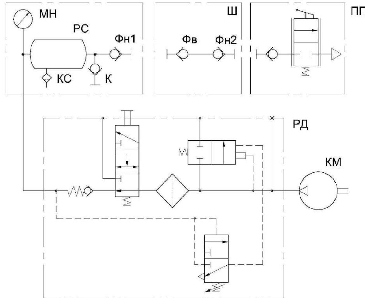
КМ - компрессор; РС – ресивер; К – клапан; КС – кран слива конденсатора; МН – манометр; Фн – фитинг; Ш – шланг; ПП – пневмопистолет обдувочный; Фв – фитинг; Фн2 – фитинг; РД – регулятор давления
