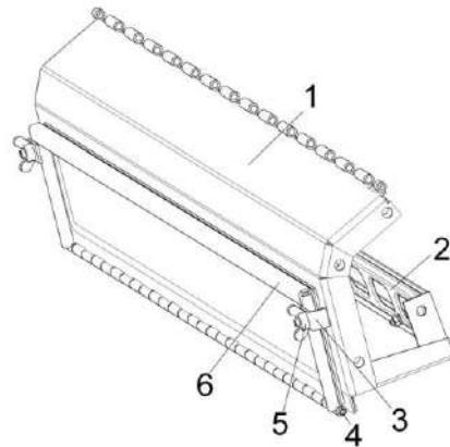
1 – основание; 2 – щит; 3 – прижим; 4 – ось; 5 – гайка-барашок; 6 – крышка
