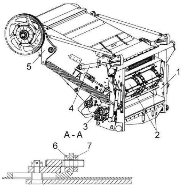
1 – рамка переходная; 2 – цепочно-планчатые транспортеры; 3 – гидромотор; 4 – гидроцилиндр; 5 – механизм продольного копирования; 6, 7 – гайки;
