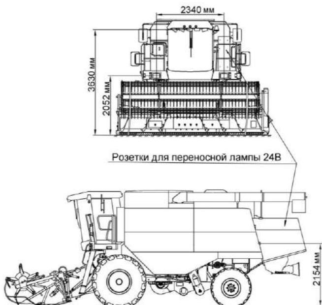
Рисунок 1.30 – Расположение наружного освещения и световой сигнализации комбайна
