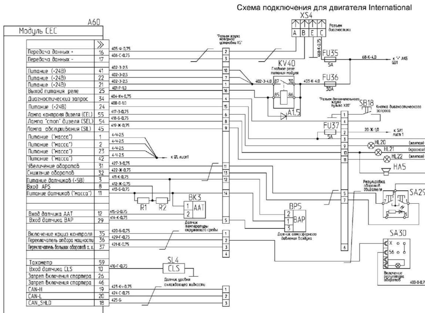
Рисунок Б.9 – Схема электрическая принципиальная комбайна (лист 9)
