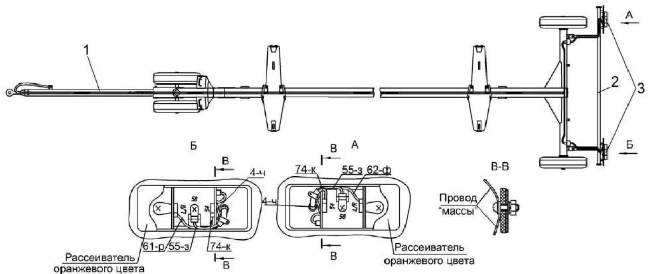
1 – рама тележки; 2 – балка габаритная; 3 – фонари
