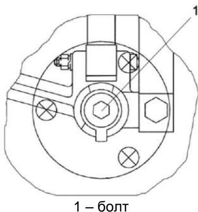
Рисунок 2.23 - Регулировка усилия на рычагах
