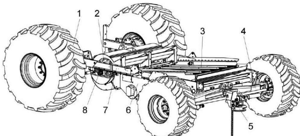
1 – мост ведущих колес; 2 – вентилятор; 3 – стан решетный нижний; 4 – мост управляемых колес; 5 – устройство тяговое; 6 - блок шнеков; 7 – рама; 8 – опора
