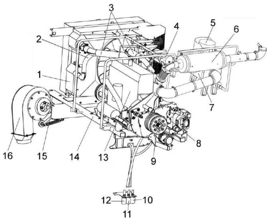
1 – радиатор; 2 – труба водяная верхняя; 3 – трубы воздушные; 4 - бачок расширительный; 5 – воздухозаборник вращающийся; 6 – глушитель; 7 – воздухозаборник; 8 – установка гидронасосов; 9 – главный привод; 10 – сливной рукав охлаждающей жидкости; 11 – сливной рукав масла из редуктора; 12 – сливной рукав масла из картера двигателя; 13 – двигатель; 14 – рама подмоторная; 15 – устройство натяжное; 16 – вентилятор
