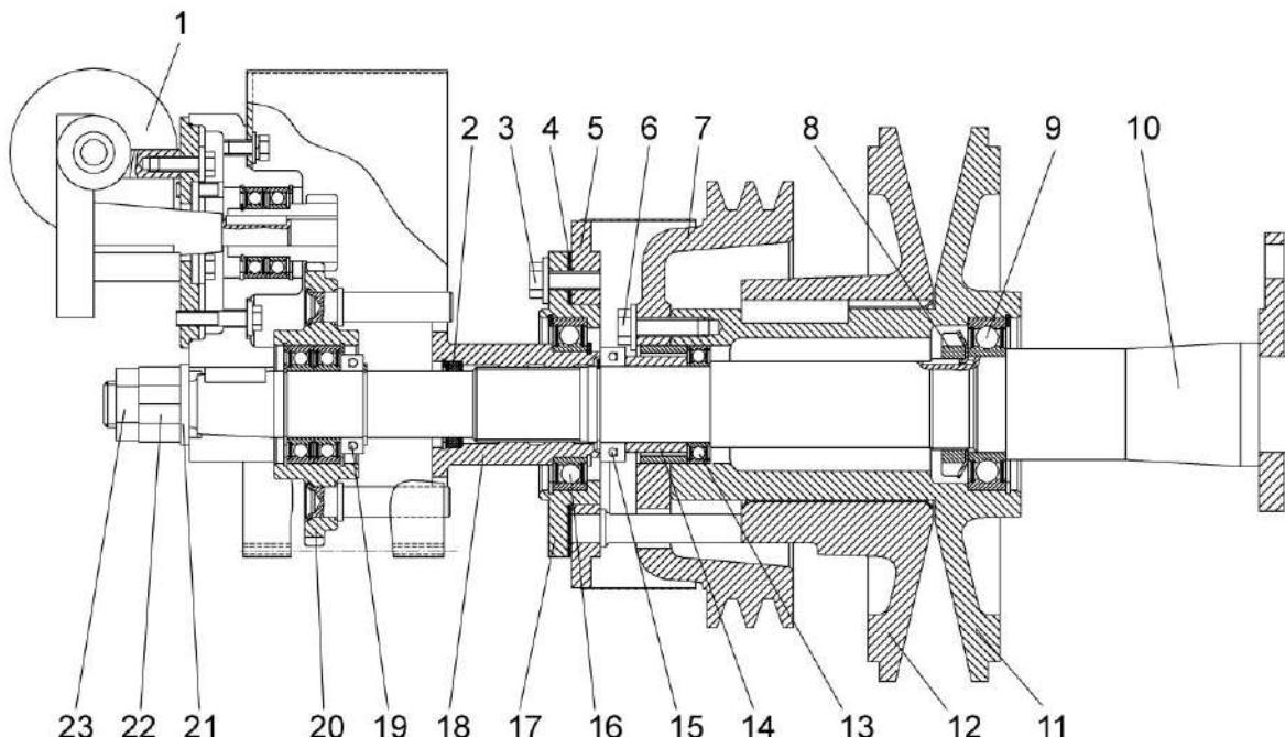
1 – привод; 2, 4 – прокладки; 3, 6 – болты; 5 – упор; 7, 11, 12 – шкивы; 8, 22, 23 – гайка; 9, 13, 15, 16, 19 – подшипники; 10 – ось; 14, 18 – втулки; 17 – корпус; 20 – колесо; 21 - шайба
