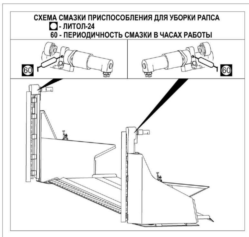
Рисунок 3.1 – Схема смазки приспособления
