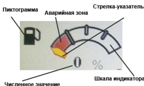
Рисунок Н.3– Пример стрелочного индикатора
