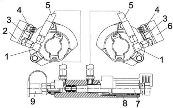
Рисунок 1.30 - Гидросистема регулировки зазора между вальцами доизмельчающего устройства
