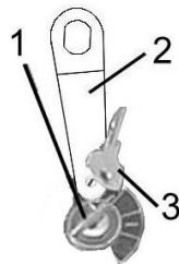
1 – замок зажигания; 2 – ключ специальный для открывания капотов; 3 – ключ от замка зажигания
