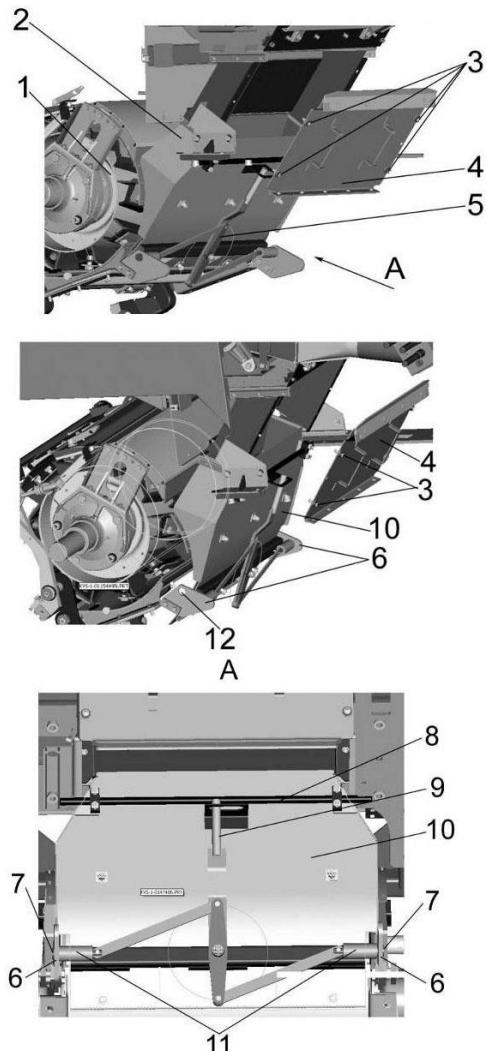
1 – барабан измельчающий; 2 – проставка; 3 – фиксаторы быстросъемные; 4 – стенка съемная; 5 – механизм открытия приемной камеры; 6 – направляющие; 7 – фиксаторы; 8 – ось; 9 – рычаг; 10 – приемная камера; 11 – втулки; 12 – отверстия для фиксации
