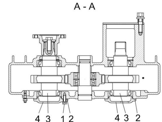
1 – болты; 2 - прокладки; 3 – вал-шестерня; 4 – крышка
