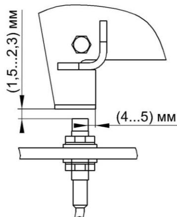
Рисунок 2.13 – Установка датчика положения бруска абразивного
