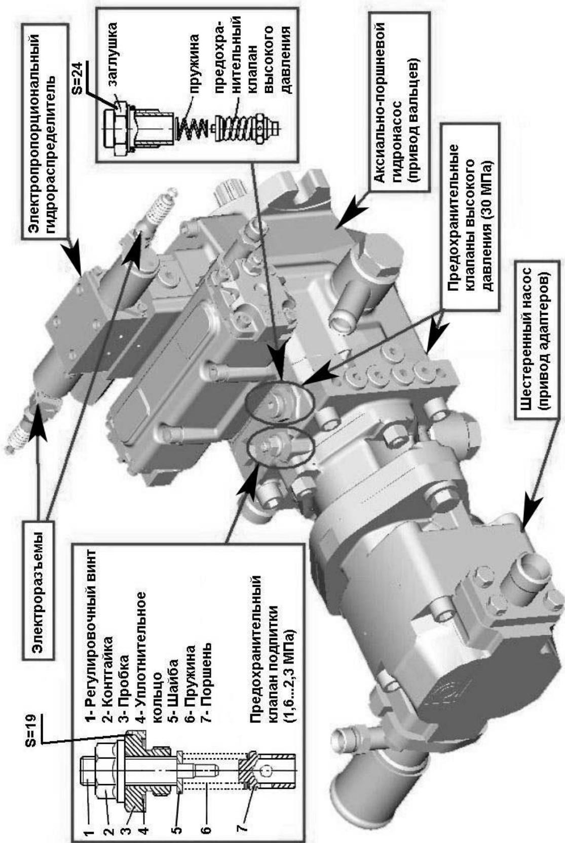
Рисунок 4.8 – Гидронасос двухсекционный
