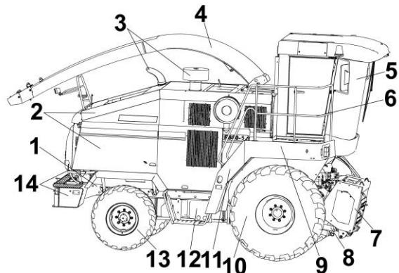
1 – рама; 2 – капоты; 3 – установка двигателя; 4 - силосопровод; 5 - кабина; 6 - поручень; 7 - аппарат питающе - измельчающий; 8 - механизм вывешивания; 9 - площадка входа; 10 - мост ведущий; 11 - трап; 12 - топливный бак; 13 - мост управляемых колес; 14 – место установки АКБ
