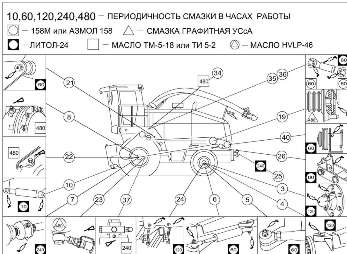
Рисунок 3.13 – Схема смазки измельчителя (вид слева)
