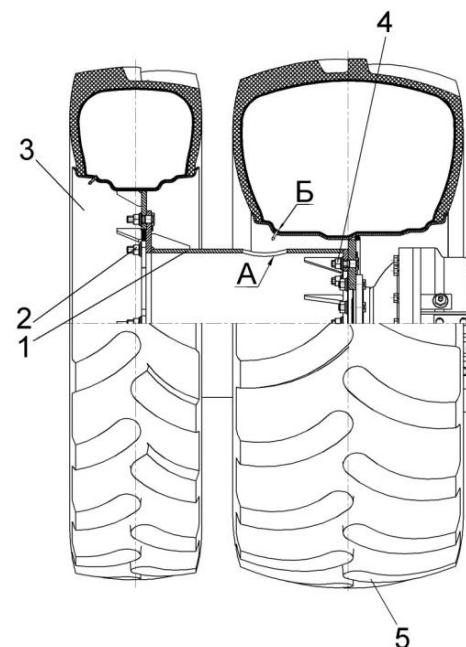
1 - проставка; 2, 4 - гайки; 3, 5 - колеса
