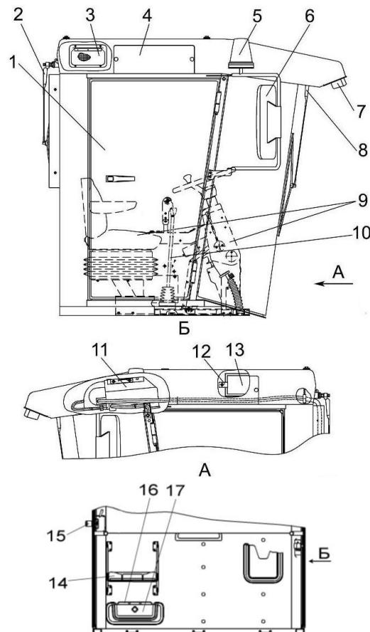
1 – дверь; 2 – задний стеклоочиститель; 3 – клапан; 4 – крышка; 5 – маяк проблесковый; 6 – зеркало; 7 – рабочие фары; 8 – передний стеклоочиститель; 9 – площадка управления; 10 – рычаг переключения передач; 11 – испаритель; 12 – прижим; 13 – фильтр; 14 – дополнительное сиденье; 15 – ручка дверная; 16 – аптечка; 17 – держатель аптечки
