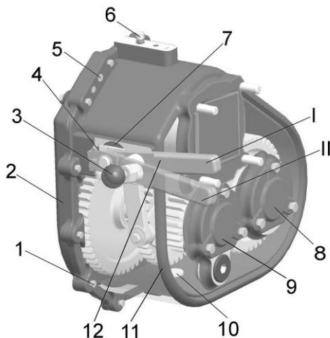
1 – болт; 2, 11 – корпуса; 3 – ручка шаровая; 4 - клеммовое соединение; 5 - штифт; 6 – сапун; 7 - пробка; 8- крышка вала привода нижних вальцов; 9 - крышка промежуточного вала; 10 – пробка сливная; 12 - рычаг переключения передач
