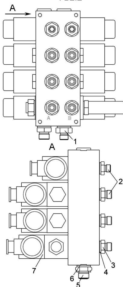
Рисунок 1.10 - Гидроблок четырехсекционный ГБ2.3
