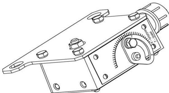
Рисунок 2.7 – Датчик камнедетектора
