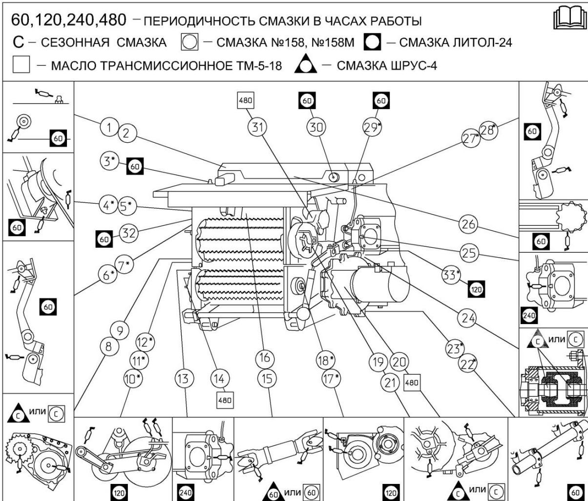
Рисунок 3.14 – Схема смазки питающе - измельчающего аппарата измельчителя
