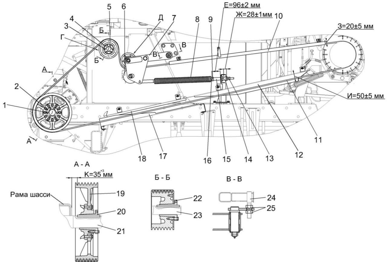
1,3 – болты; 2, 4 – пластины; 5,19 – шкивы; 6 – ролик; 7 – рычаг; 8 – пружина; 9, 13, 25 – гайки; 10, 12, 16, 17, 18 – щитки; 11 – ремень; 14 – буфер; 15 – винт; 16 – пробка; 20, 22 – ступицы; 21,23 – валы; 24 – шпилька
