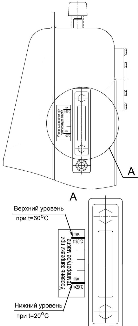
Рисунок 2.6 – Заправка гидросистем
