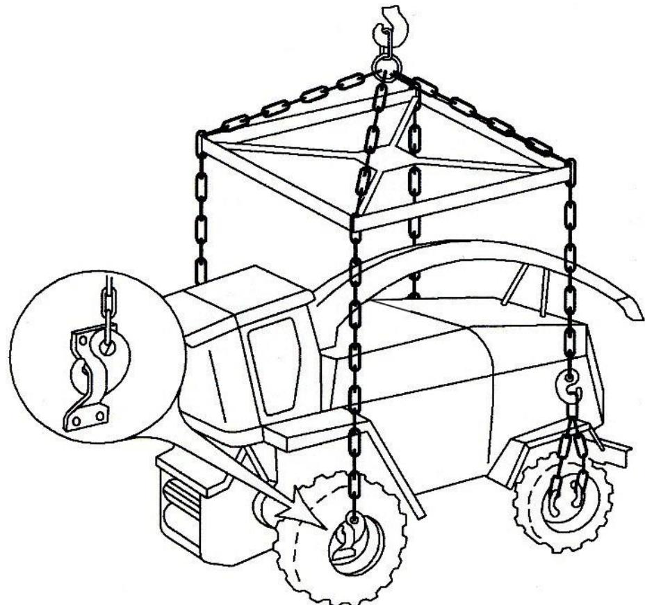
Рисунок 6.1 – Схема строповки
