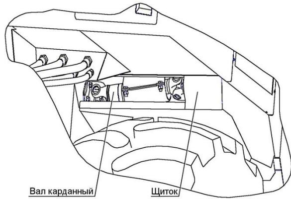
Рисунок 3.11 – Смазка шарниров карданного вала привода редуктора гидроусилителей
