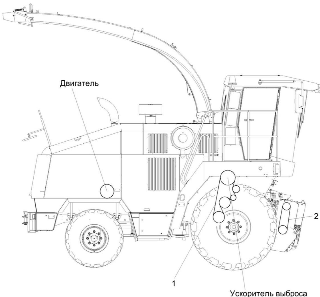
Рисунок М.2 – Схема приводов измельчителя (вид справа)
