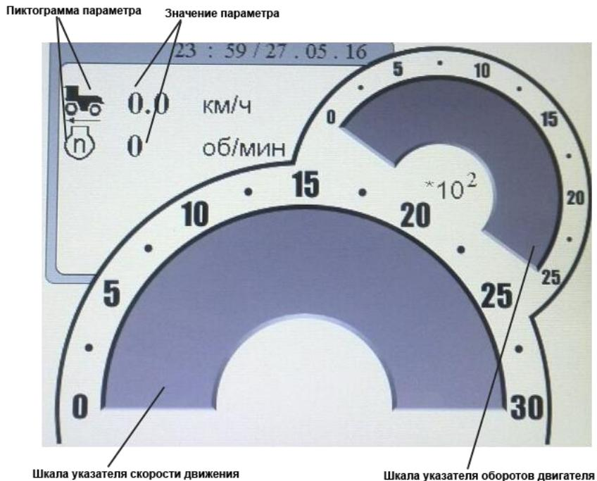
Рисунок Н.5 – Индикатор приборной панели
