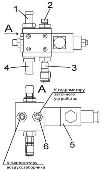
Рисунок 1.9 - Гидроблок воздухозаборника
