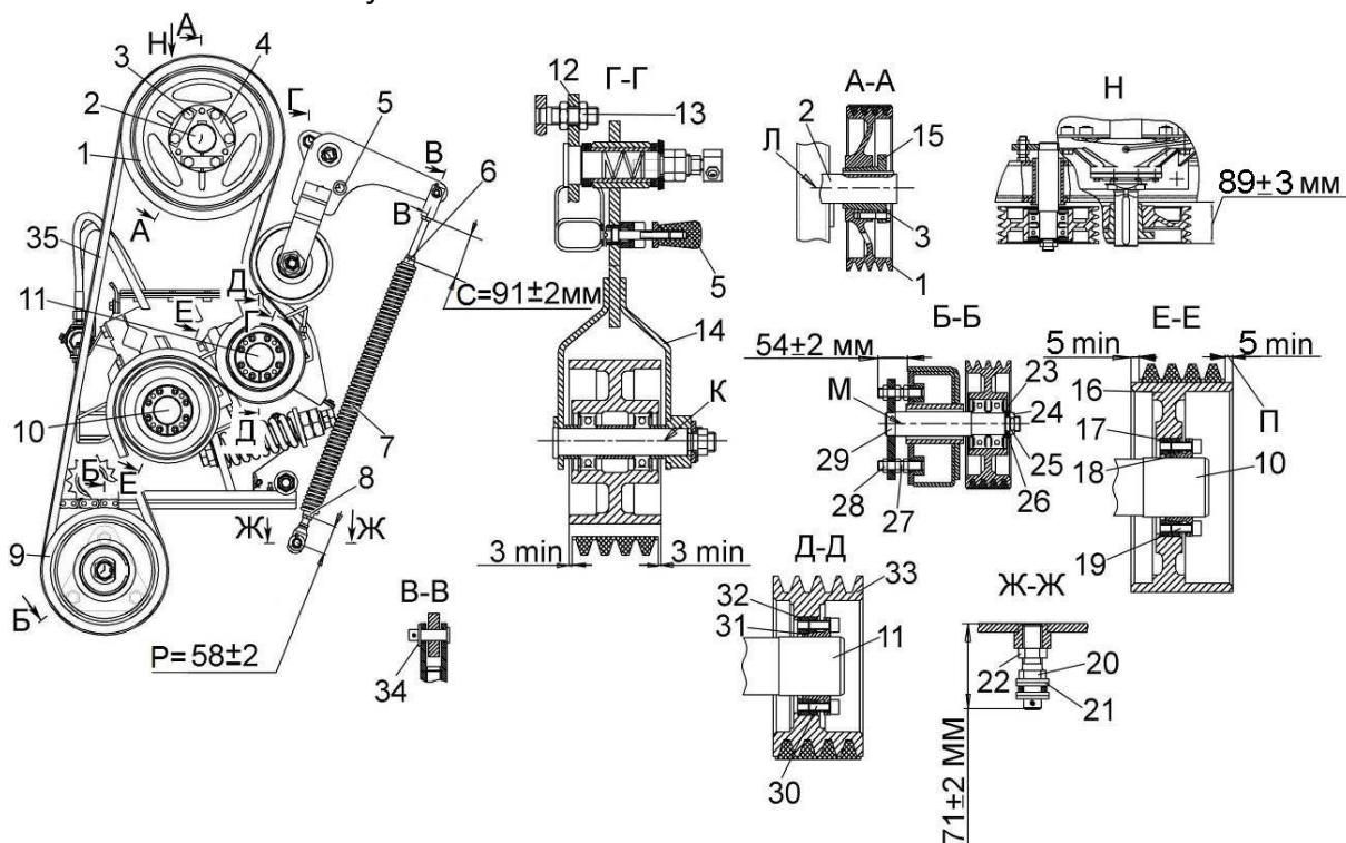
1, 33 – шкивы; 2 – вал ускорителя; 3 – болт; 4 - пластина; 5 – фиксатор;
