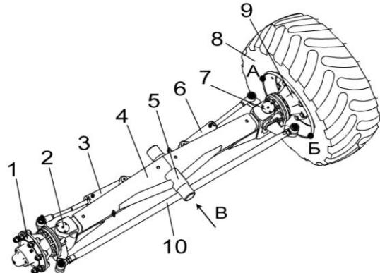
1, 9 – ступицы колес; 2, 7 – шкворни; 3, 6 – гидроцилиндры; 4 – балка моста; 5 – ось; 8 – колесо; 10 – тяга рулевая
