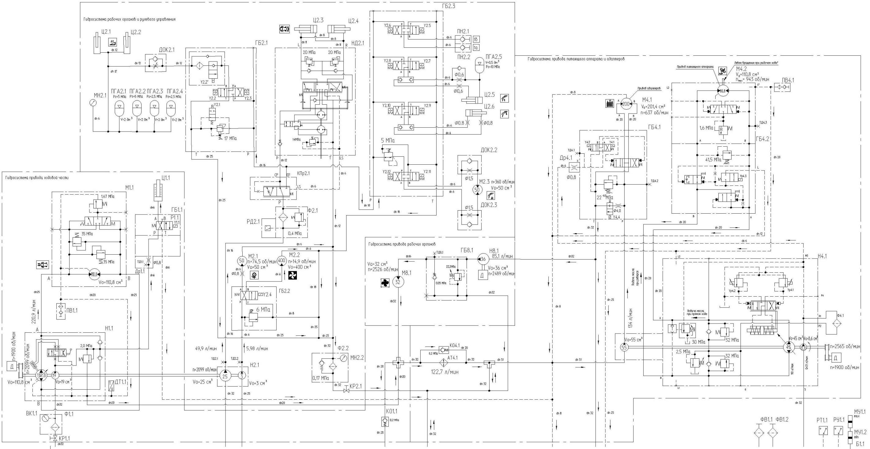
Рисунок А.1 – Схема гидравлическая принципиальная гидросистемы кормоуборочного комплекса
