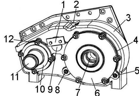
1 – упор; 2 – сапун; 3 – корпус; 4, 12 – прокладки; 5 – пробка сливная; 6, 10 – крышки; 7 – колесо; 8 – пробка контрольная; 9 – ось; 11 – вал-шестерня
