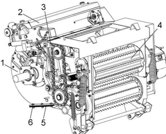
1 – аппарат измельчающий; 2 – заточное устройство; 3 - скоба; 4 – аппарат питающий; 5 – прокладки регулировочные; 6 – болт
