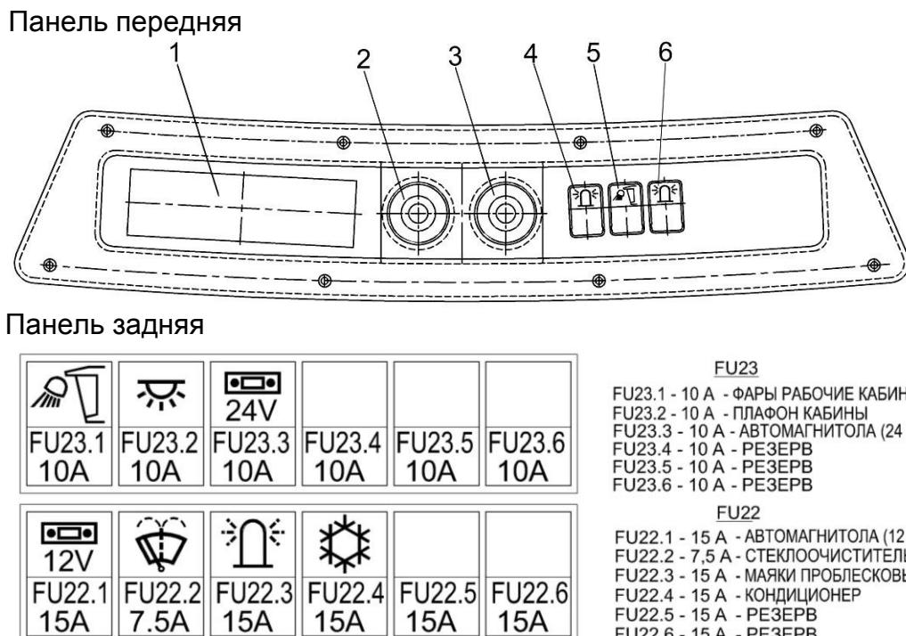
1 – место установки радиоприемника; 2 – ручка переключателя переднего стеклоочистителя и омывателя; 3 – ручка переключателя заднего стеклоочистителя и омывателя; 4 – выключатель маяков проблесковых кабины; 5 – выключатель рабочих фар кабины; 6 – выключатель заднего маяка проблескового
