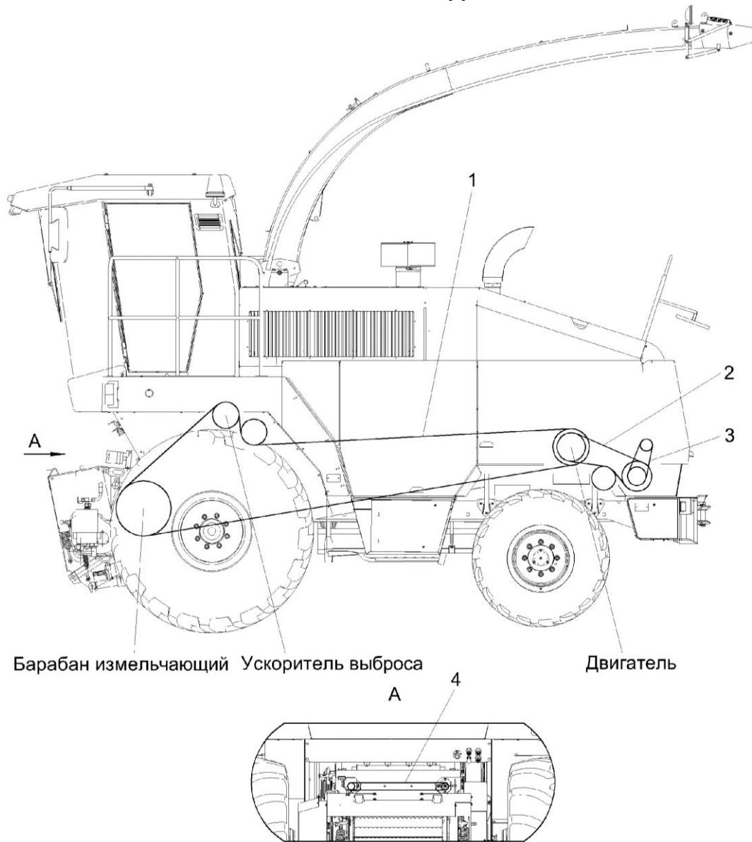
Рисунок М.1 – Схема приводов измельчителя (вид слева)
