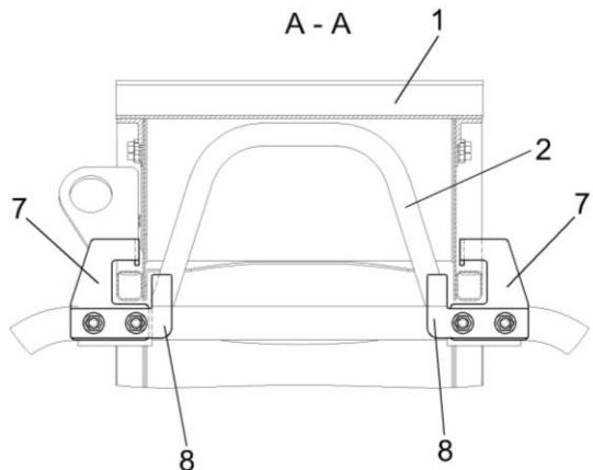
Рисунок 2.3 – Механизм фиксации силосопровода
