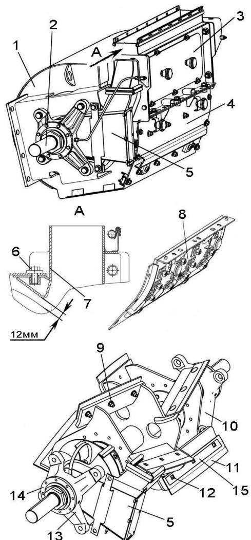
1 – корпус ускорителя; 2 – вал ускорителя выброса; 3 – стенка задняя; 4 – поддон; 5 – воздуховод; 6, 12 – болты; 7 – отсекатель; 8 – поддон бичевой; 9 – гайка; 10, 13 - корпуса; 11 – лопасть; 14 – крышка; 15 – накладка
