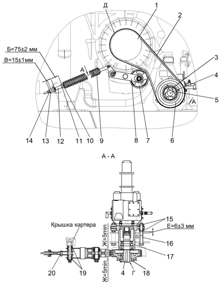
1, 6 – шкивы; 2 – ремень; 3, 16 – болты; 4 – вал; 5 – пластина; 7 - ролик; 8 – рычаг; 9 – пружина; 10 – пробка; 11, 14, 15 – гайки; 12 – винт; 13 – амортизатор; 17 – установка насоса трехсекционного; 18 – ступица; 19 – шайбы; 20 – ось
