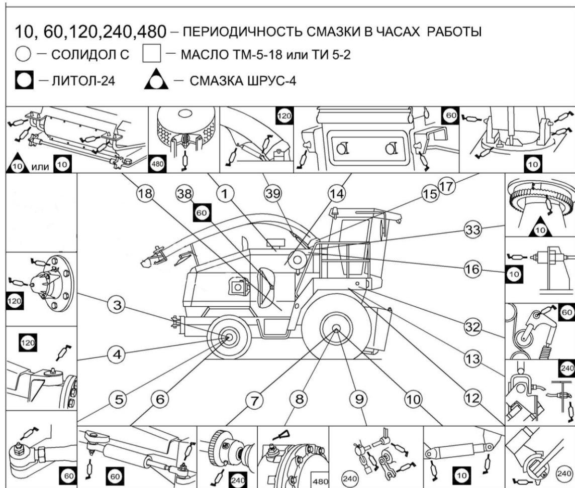
Рисунок 3.12 – Схема смазки измельчителя (вид справа)
