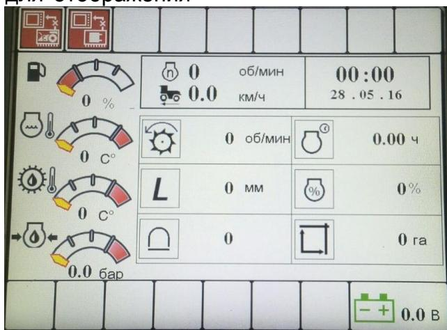
Рисунок Н.7 – Экран комбайнирования
