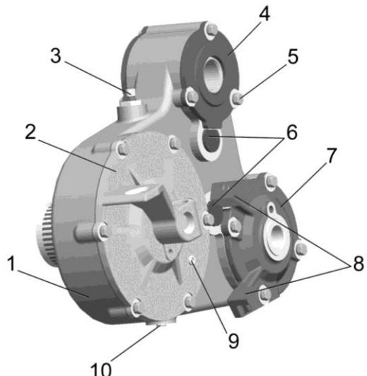
1- корпус; 2, 4, 7 – крышки; 3 – сапун; 5 - болт; 6 - оси; 8 - ограничители угла поворота рычага верхних вальцов; 9 – пробка контрольная; 10 – пробка сливная
