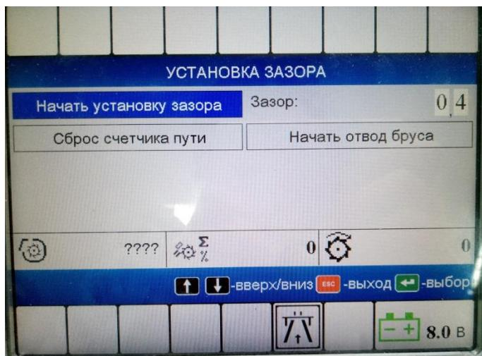
Рисунок Н.21 – Меню установки зазора
