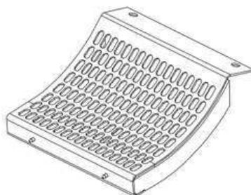
Рисунок 1.9 – Пробивная дека
