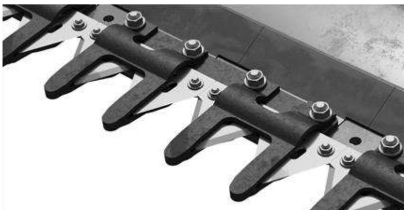
Рисунок 2.2а – Режущий аппарат
