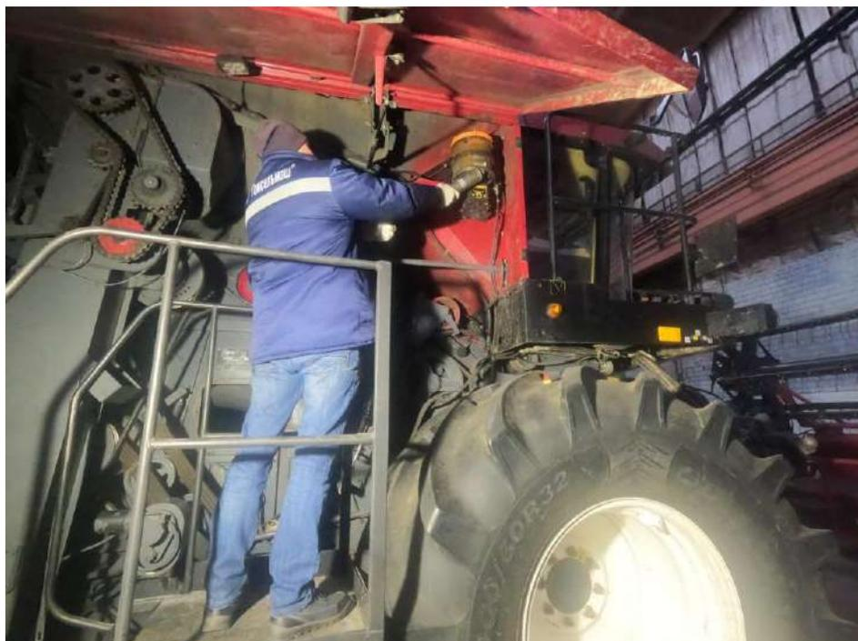
Рисунок 3.4 – Заправка насоса АЦСС
