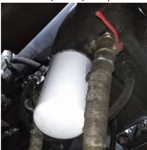
Рисунок 3.10 – Вид на перекрытый кран сливного фильтроэлемента
