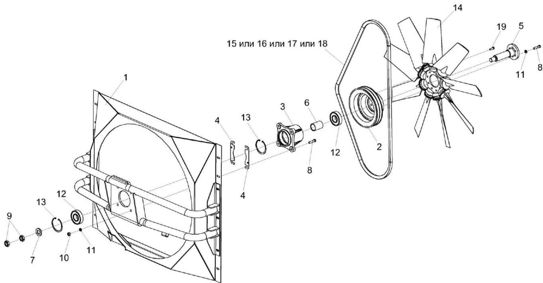
Рисунок 126 – Привод вентилятора УЭС-6-1-0400200
