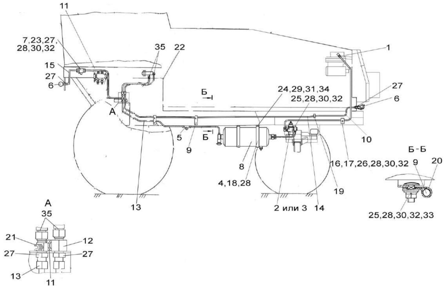
Рисунок 161 – Пневмосистема УЭС-6-0800000
