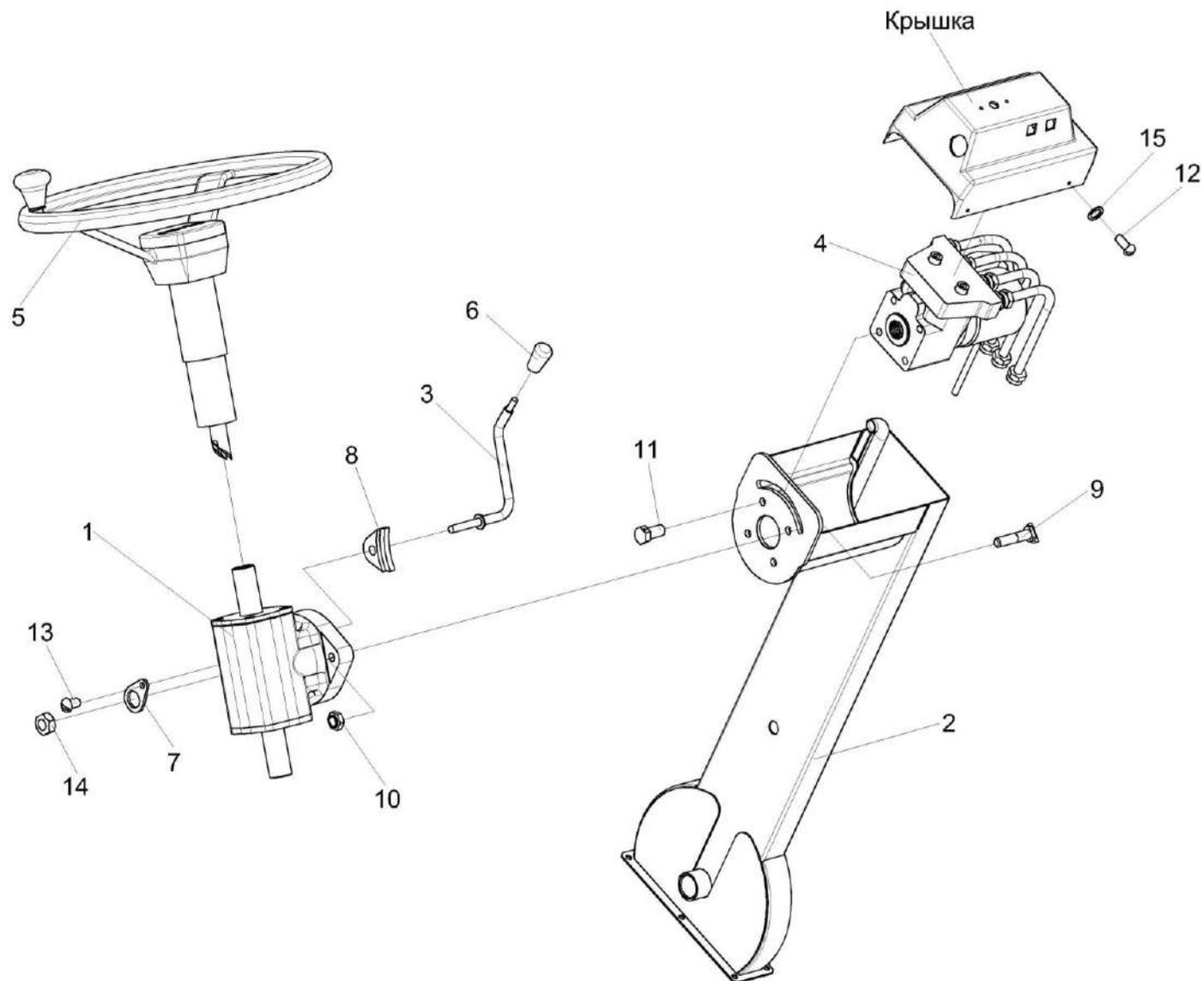
Рисунок 85 – Установка насоса-дозатора УЭС-7-0603200
