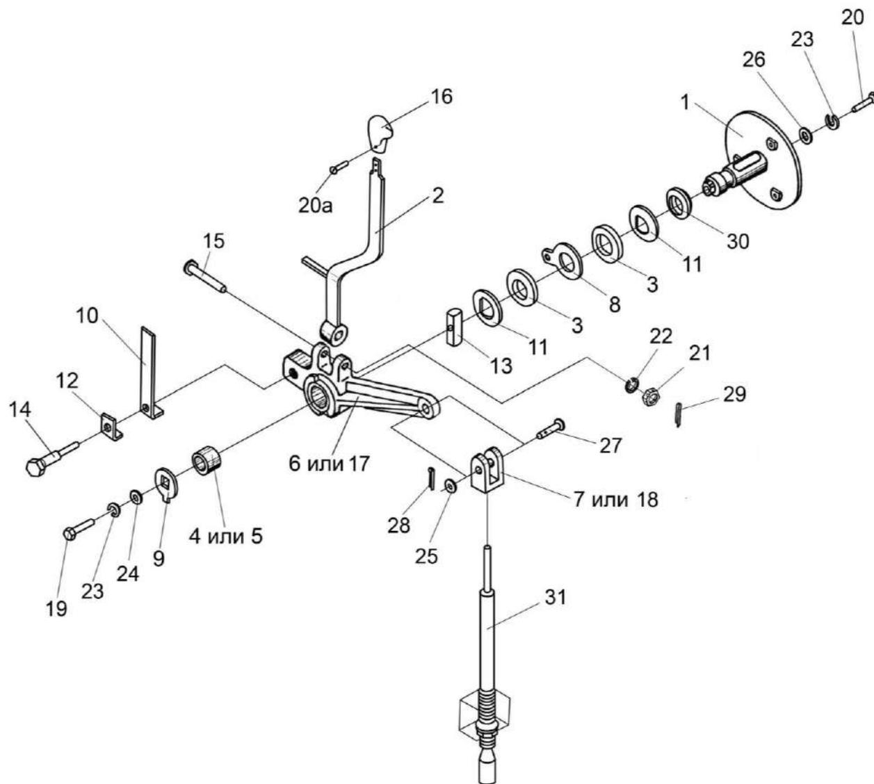
Рисунок 98 – Привод УЭС 0300970
