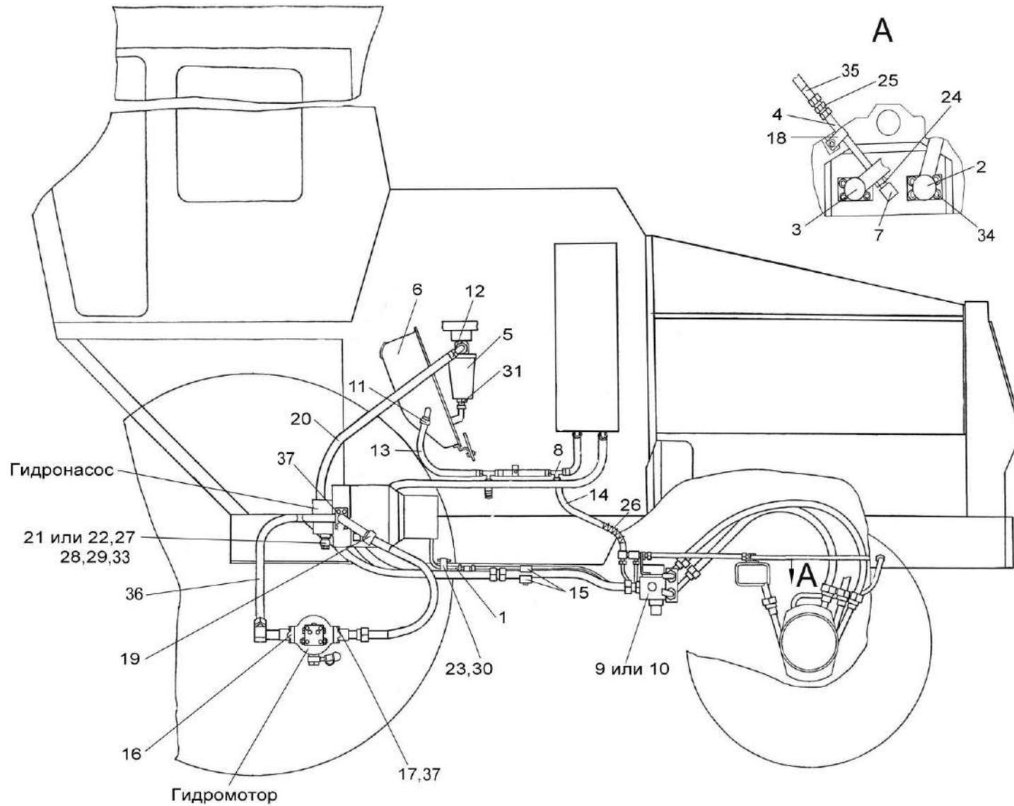
Рисунок 138 – Гидросистема привода ходовой части УЭС-6-0601000 (вид сбоку)
