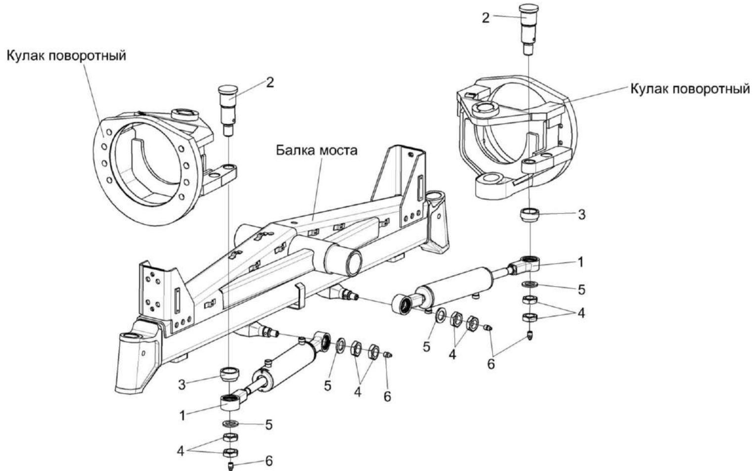
Рисунок 47 – Мост управляемых колес УМС 0109000 (установка гидроцилиндров)
