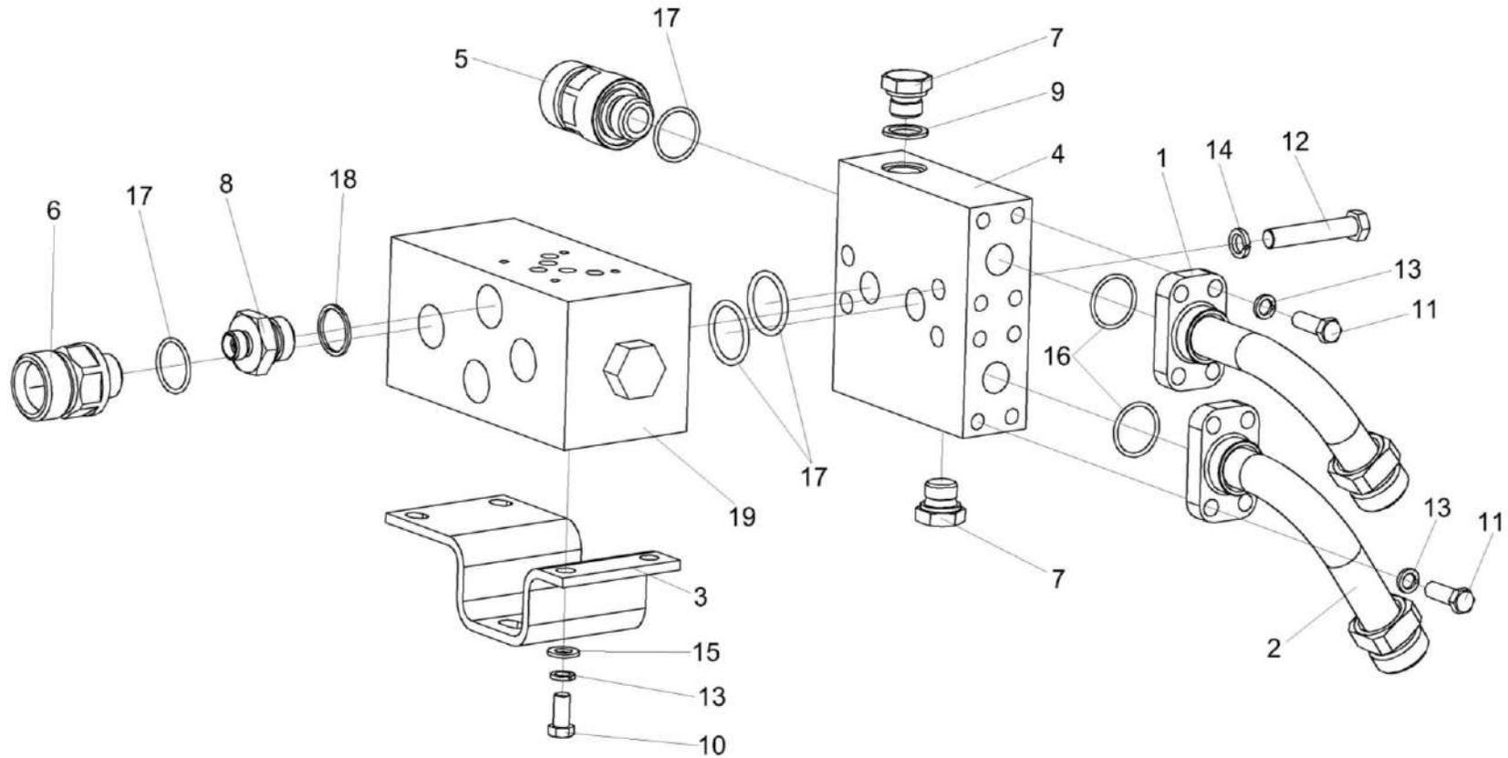
Рисунок 143 – Гидроблок подключения управляемого моста УЭС-7-0601300
