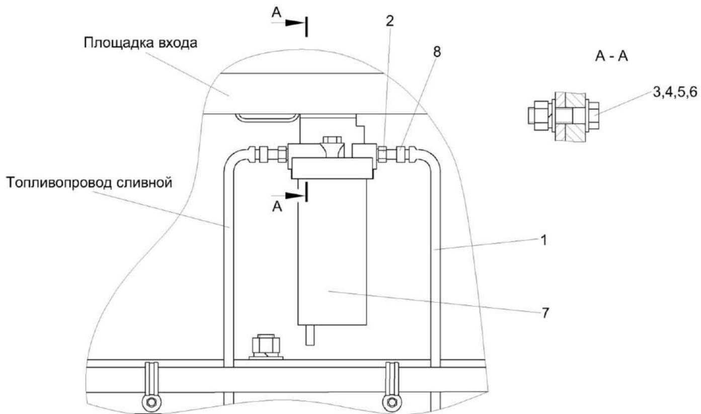
Рисунок 15 – Установка фильтра очистки топлива
