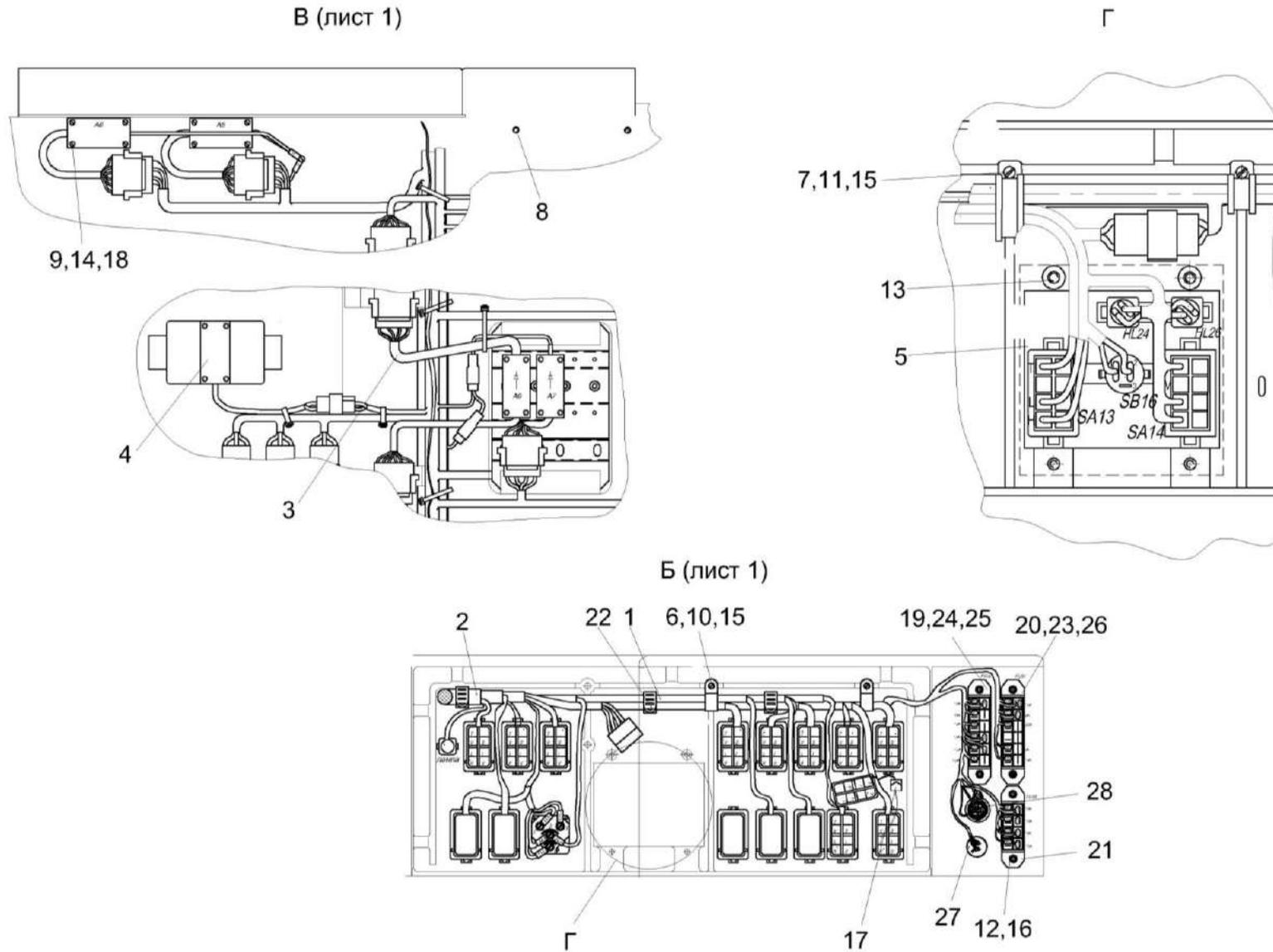
Рисунок 100 – Установка электрооборудования панели управления УЭС-6-2-0725000 (лист 2)
