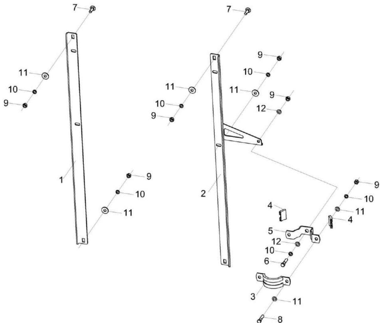
Рисунок 78 – Установка конденсатора УЭС-6-0151020
