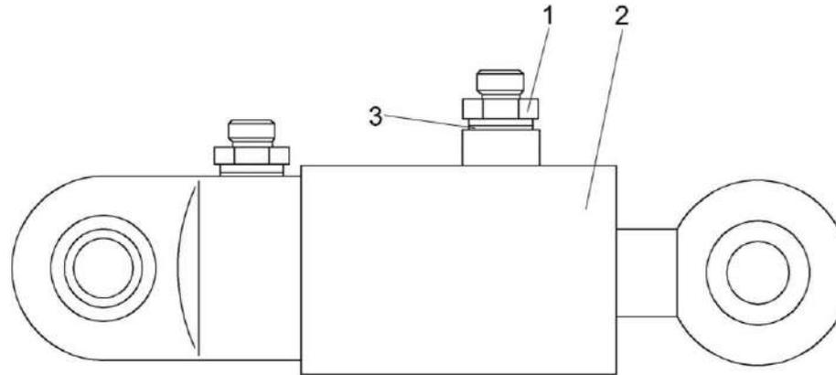
Рисунок 160 – Гидроцилиндр УЭС-7-0602200
