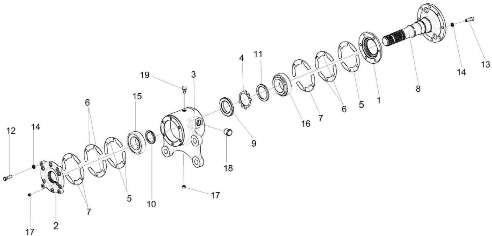
Рисунок 51 – Вал отбора мощности УМС 0115000
