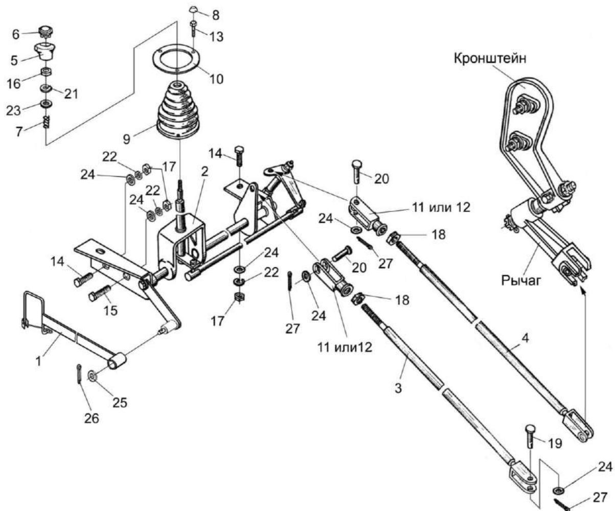
Рисунок 104 – Механизм переключения передач
