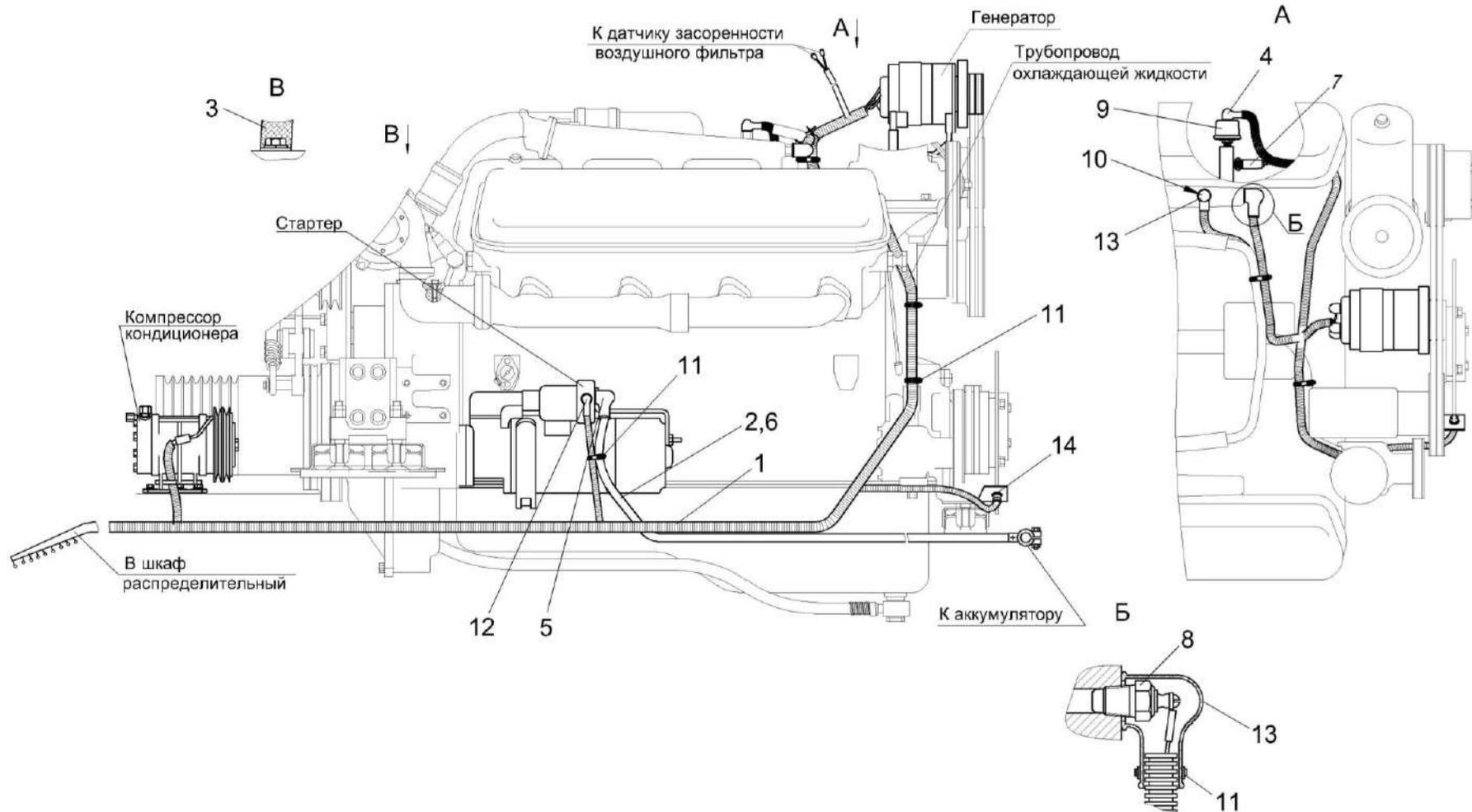
Рисунок 130 – Установка электрооборудования двигателя УЭС-6-1-0726000
