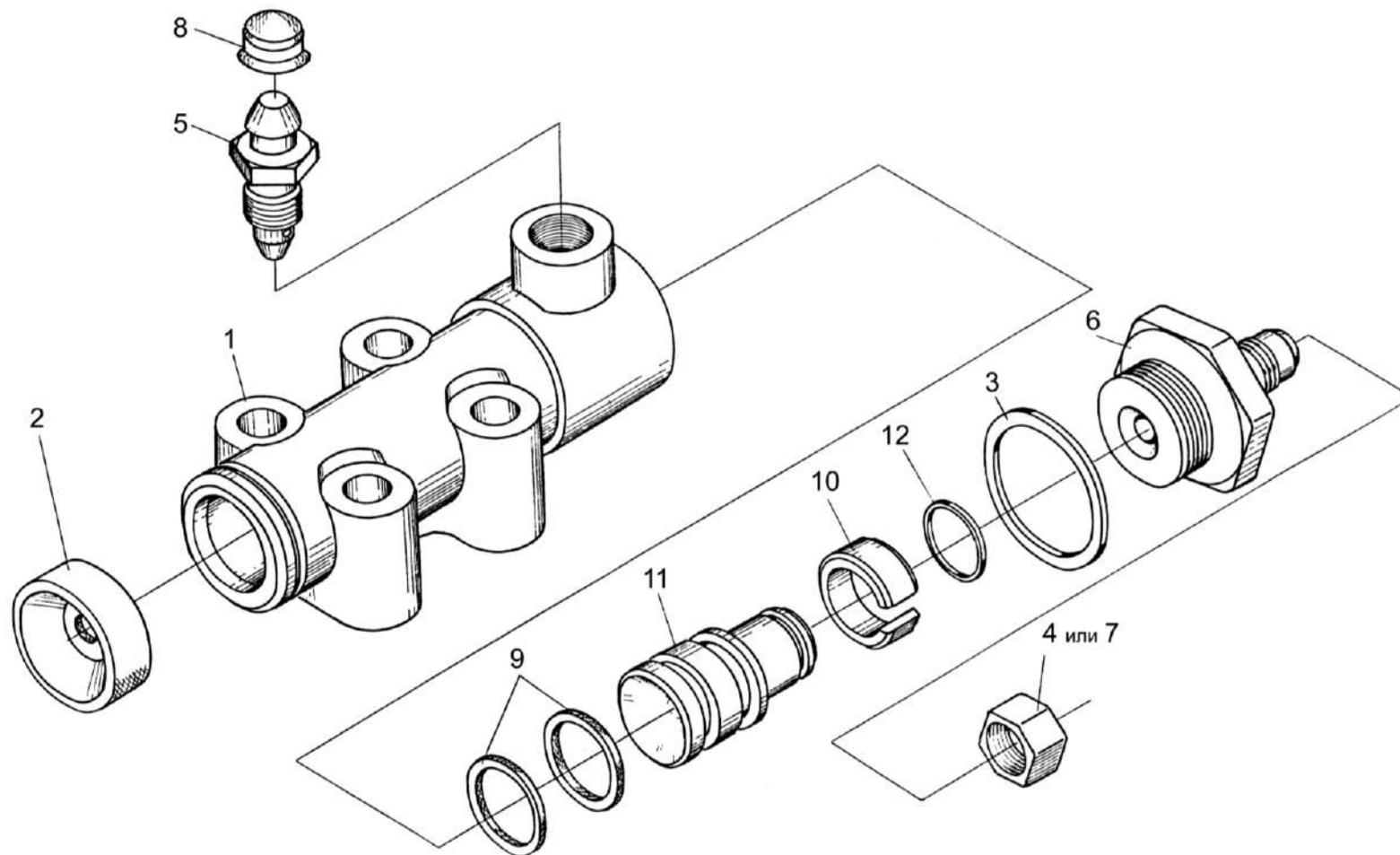
Рисунок 37 – Гидроцилиндр тормоза МК-23М.03.220А
