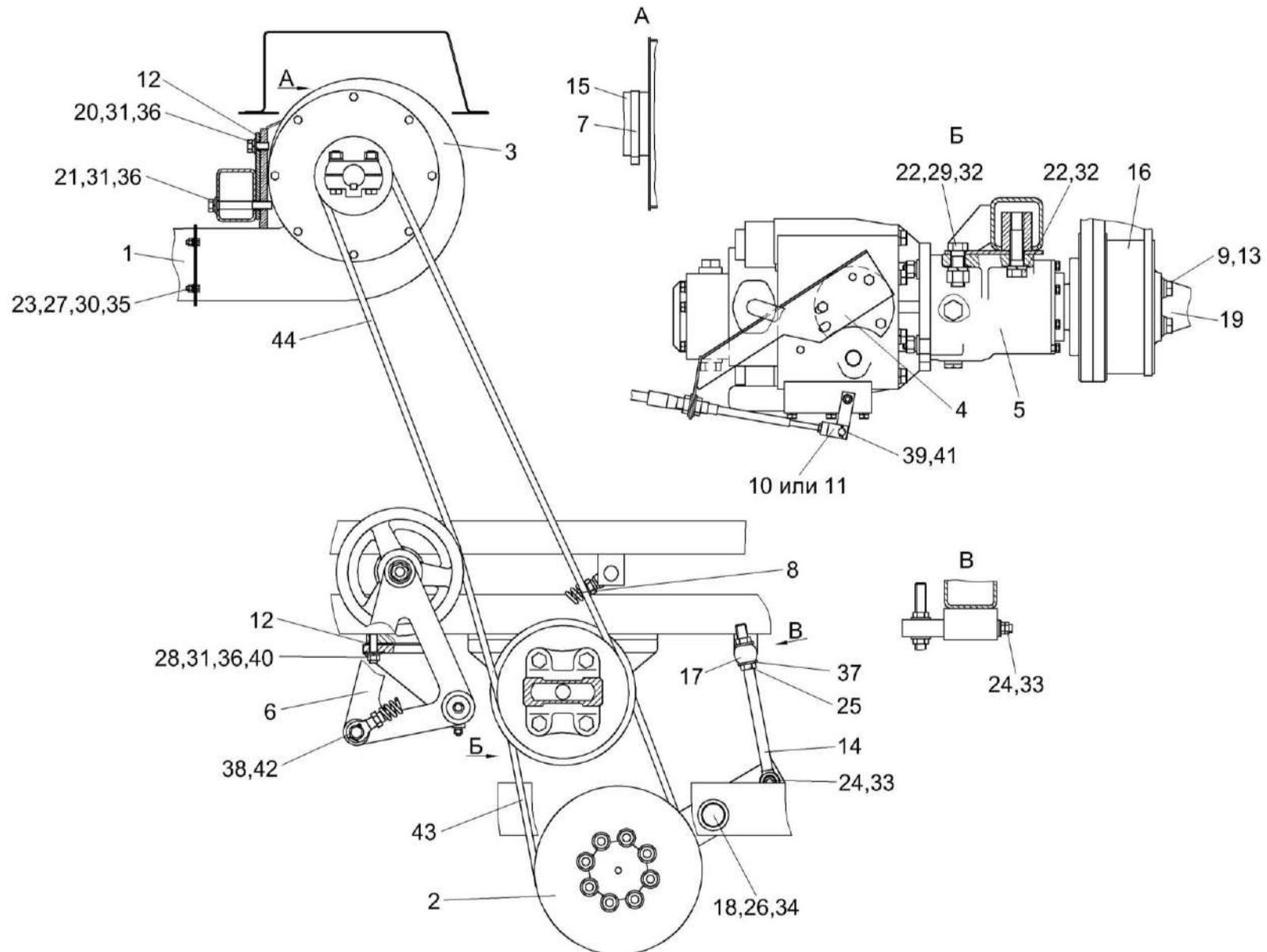
Рисунок 131 – Установка привода гидронасоса УЭС-7-1200000-02
