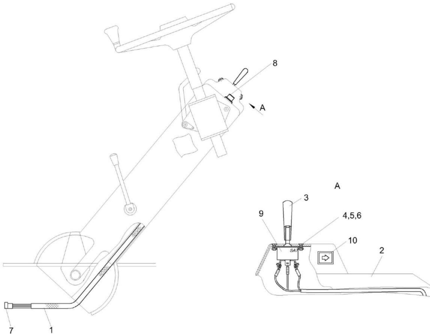
Рисунок 90 – Установка электрооборудования колонки рулевой УЭС-6-2-0723000
