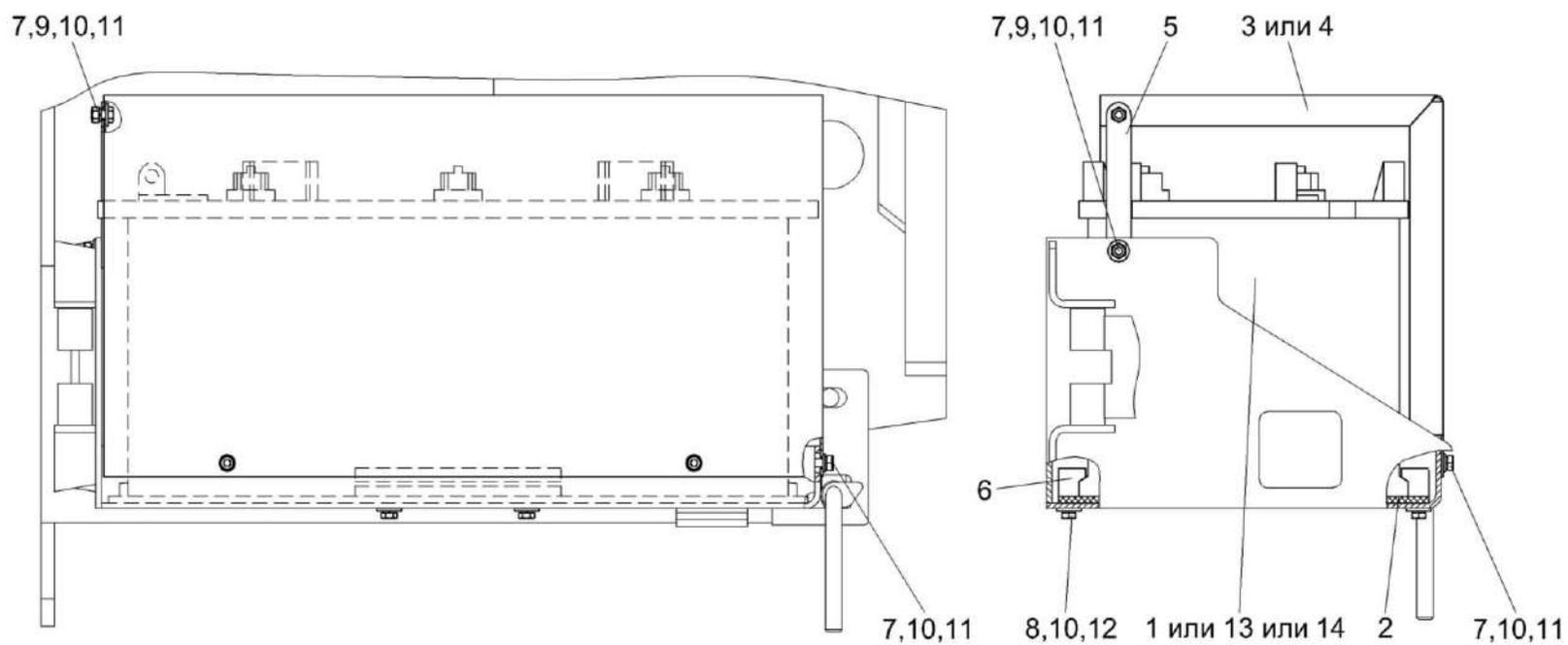
Рисунок 20 – Установка аккумуляторов УЭС 0124040 и УЭС 0124040-01
