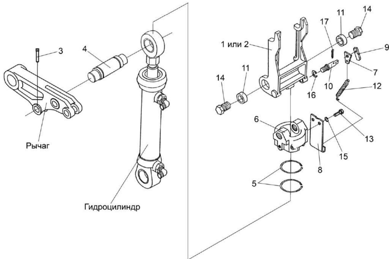
Рисунок 9 – Механизм фиксации УЭС-7-0104140А-02
