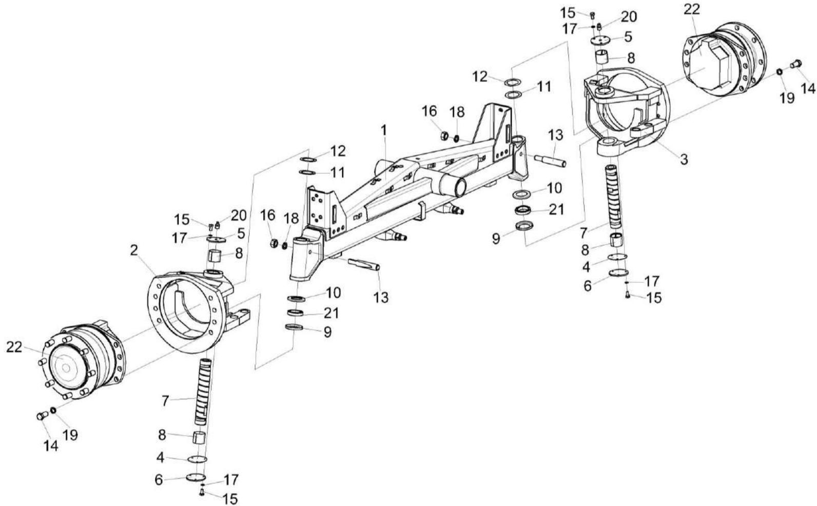
Рисунок 45 – Мост управляемых колес УМС 0109010 (установка поворотных кулаков)
