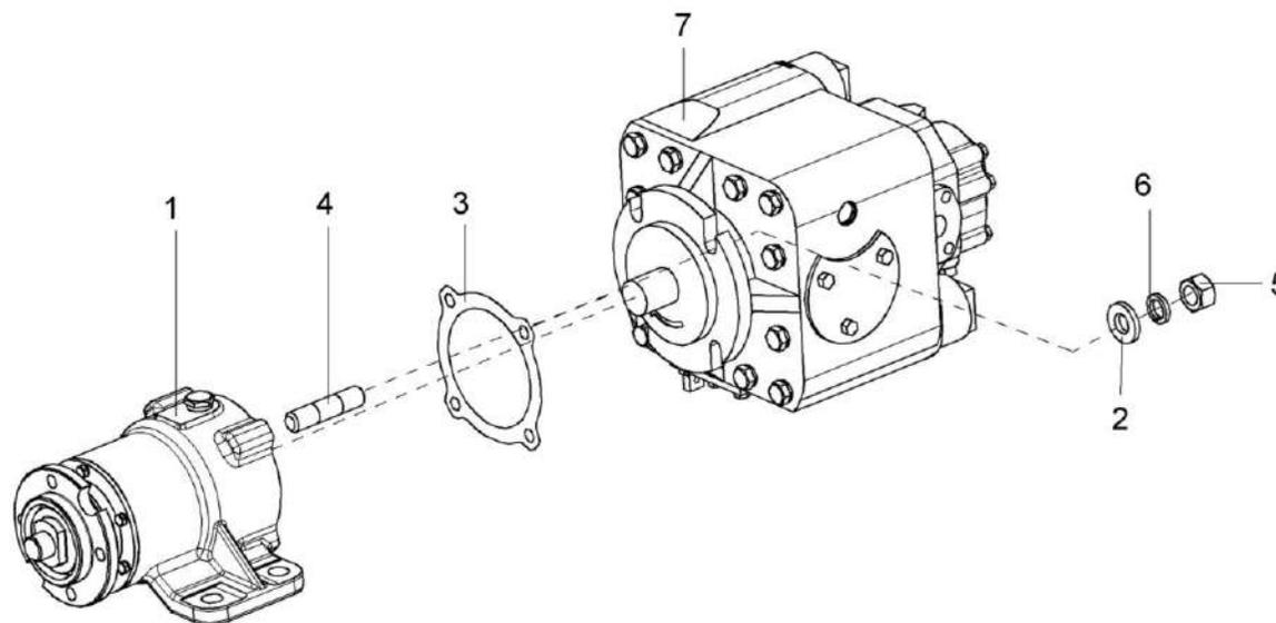
Рисунок 133 – Привод гидронасоса УЭС-7-1200000-02
