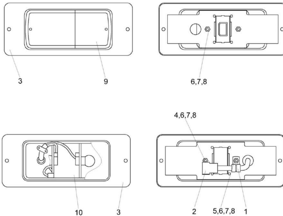
Рисунок 168 – Фонарь передний УЭС 0700910 и УЭС 0700910-02
