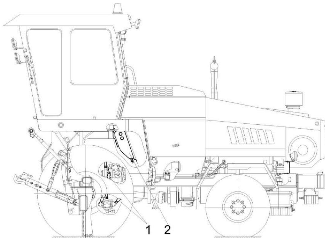
Рисунок 137 – Гидросистема УЭС-6-2-0600000
