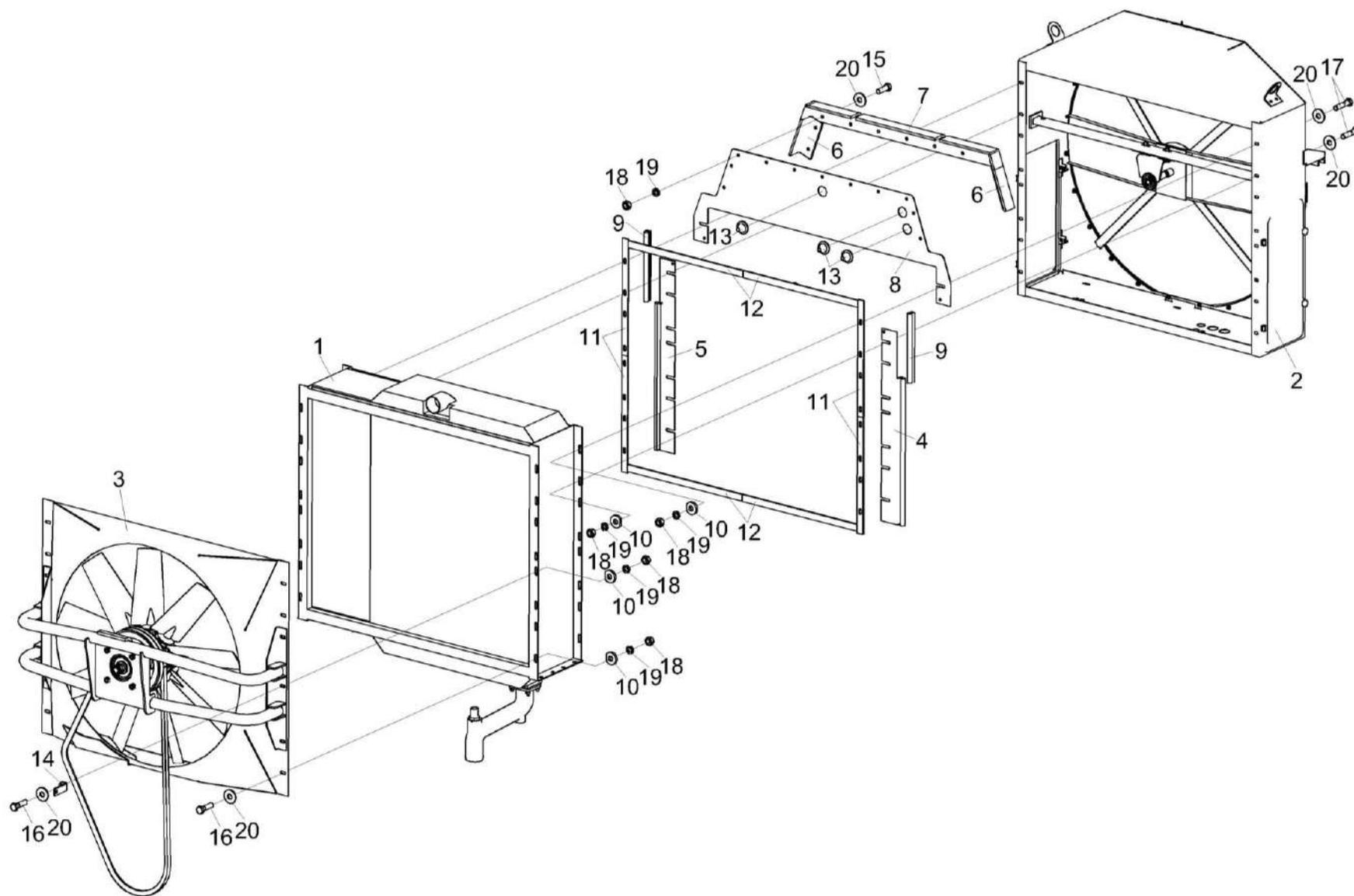
Рисунок 122 – Установка радиатора УЭС-6-1-0400040
