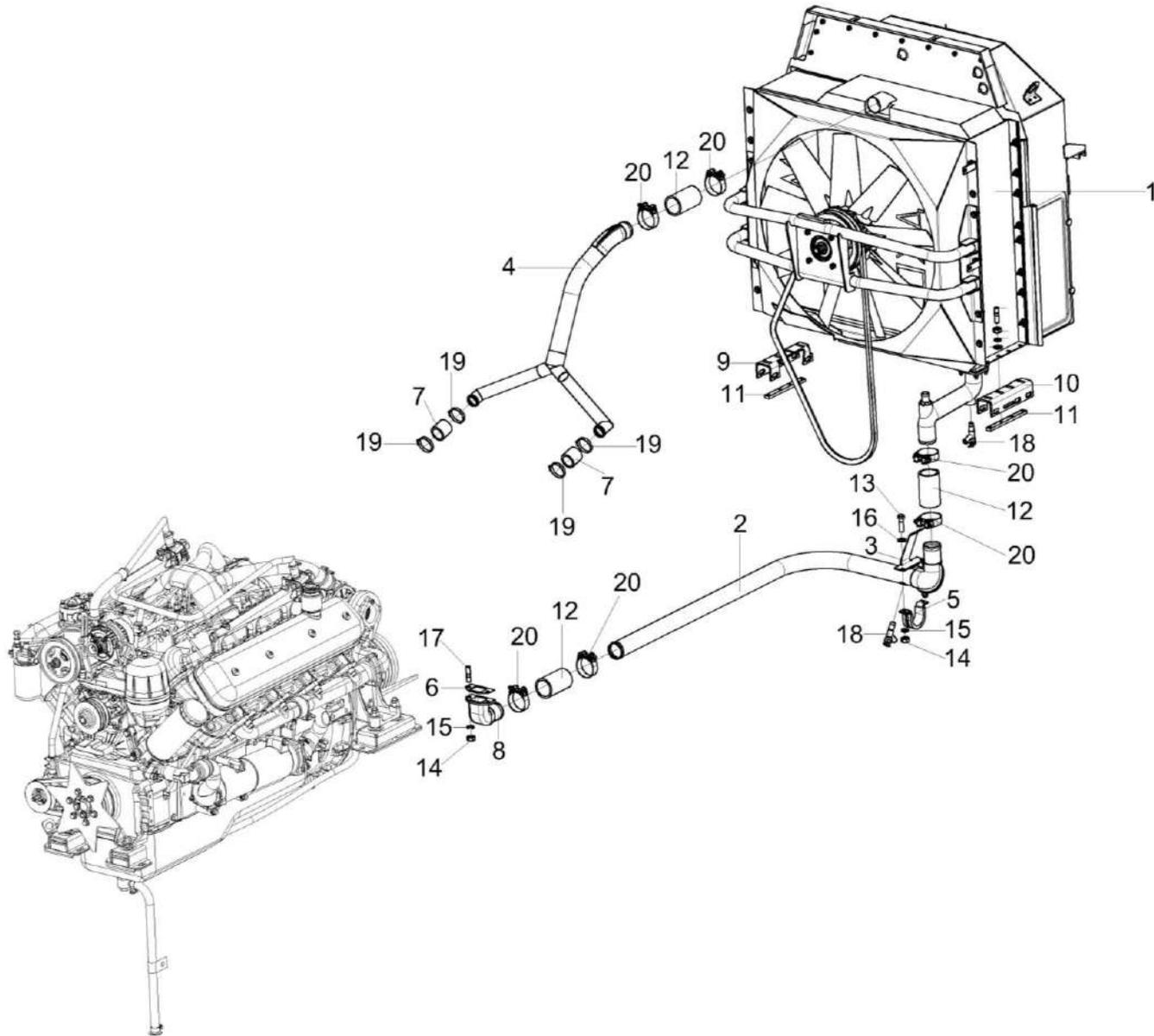
Рисунок 110 – Установка двигателя УЭС-6-1-0400000 (лист 2)
