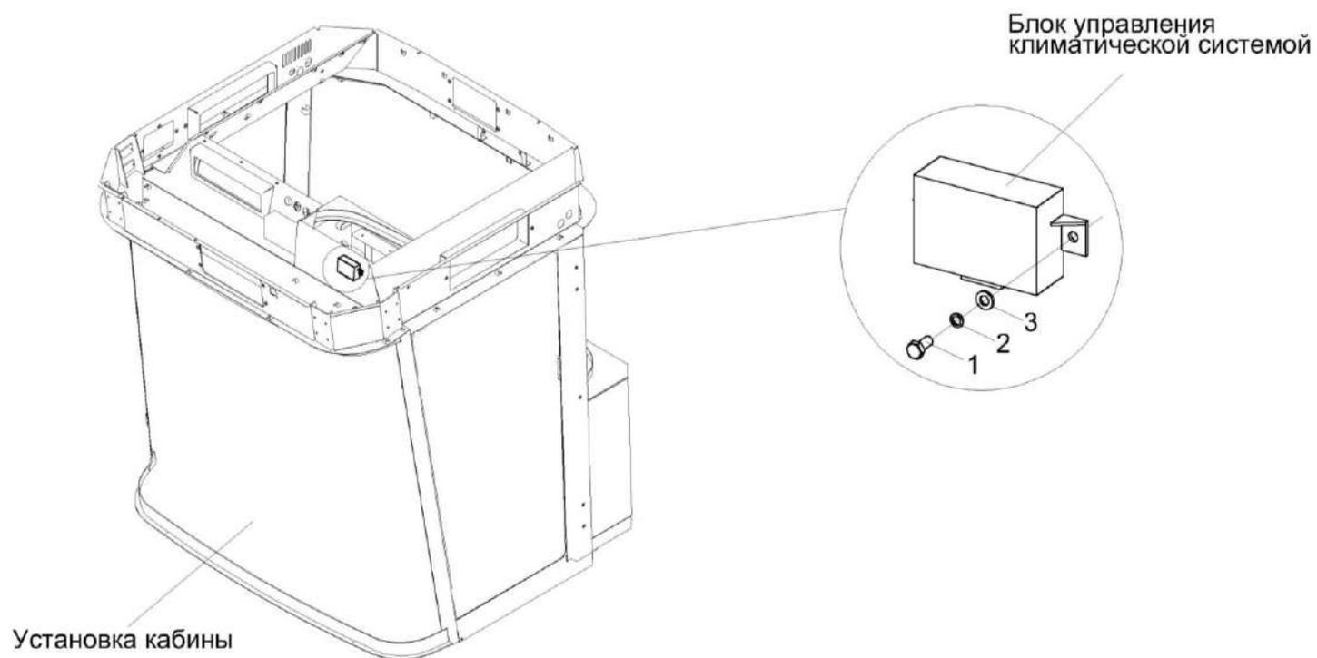
Рисунок 81 – Установка блока управления КВК-6-0121100
