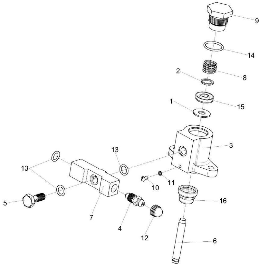
Рисунок 43 – Гидроцилиндр КЗК-12-0107200
