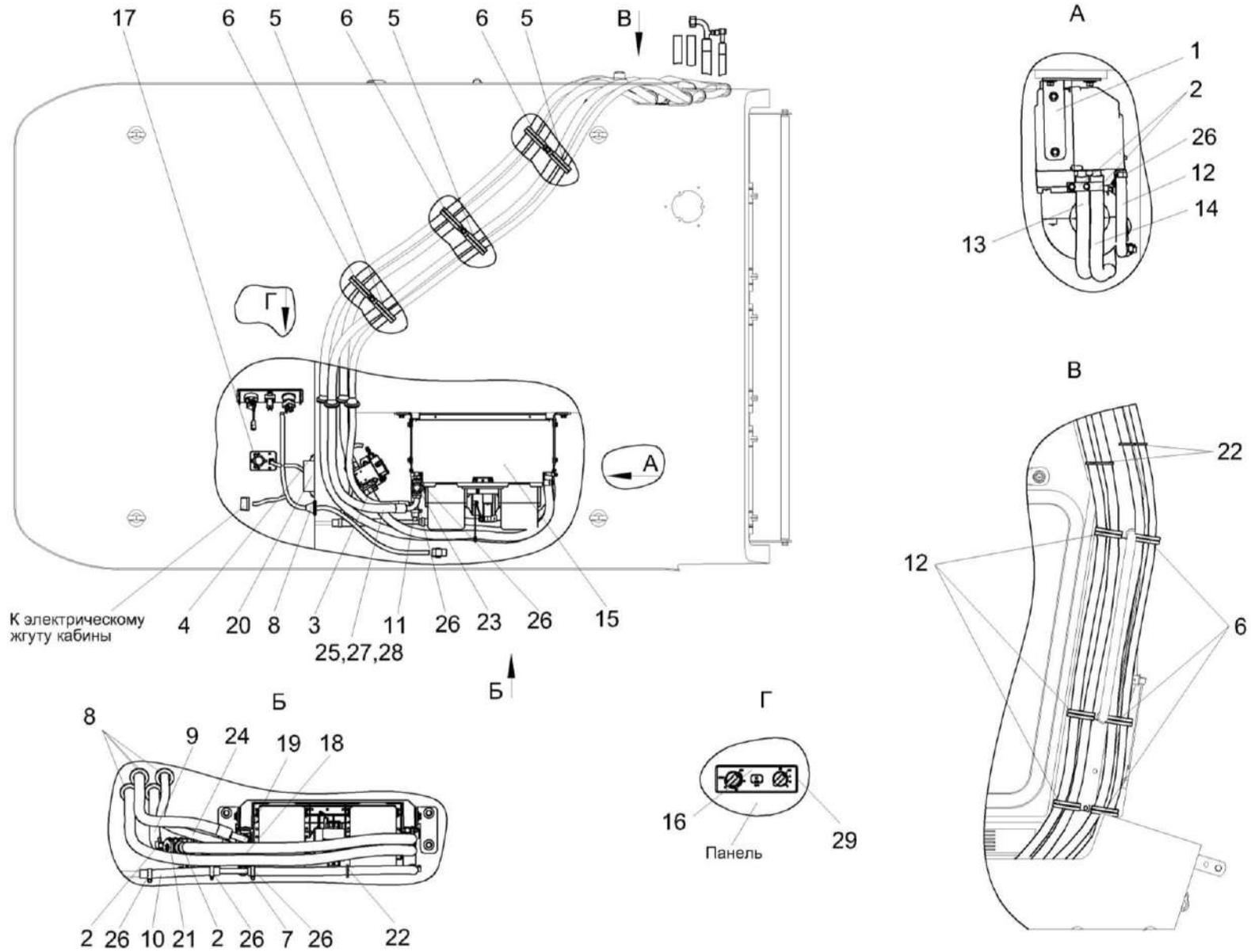
Рисунок 79 – Установка испарителя УЭС-6-2-0151020
