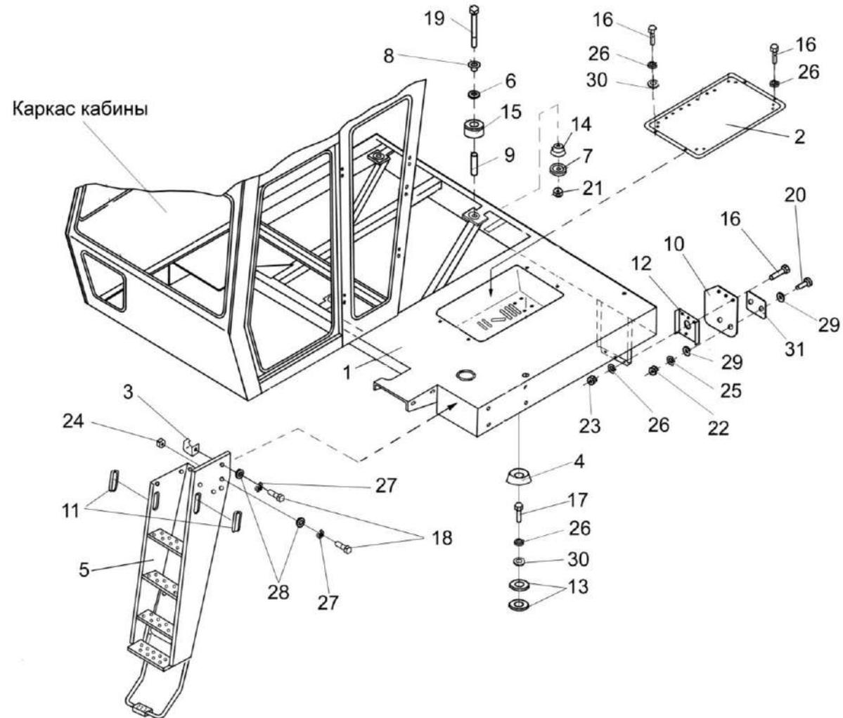
Рисунок 65 – Установка трапа УЭС-7-1000030А
