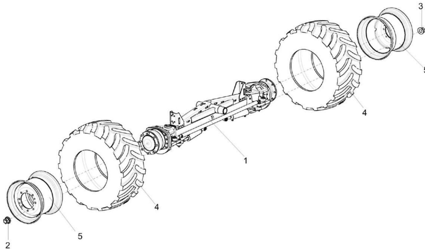
Рисунок 44 – Установка колес моста управляемых колес
