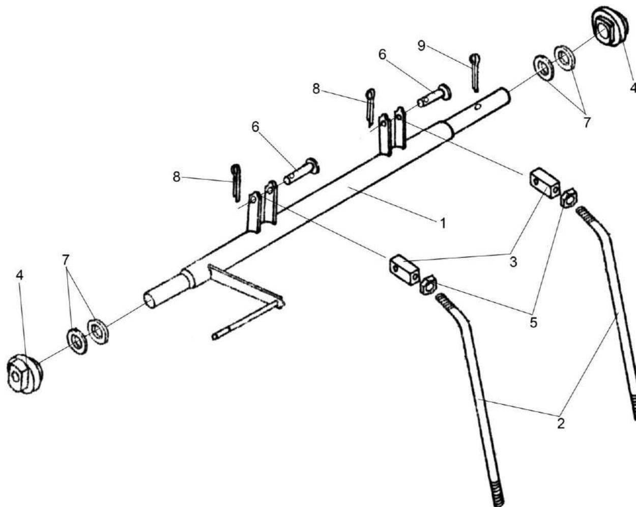
Рисунок 7 – Вал УЭС-7-0104130 и тяги УЭС-7-0104120
