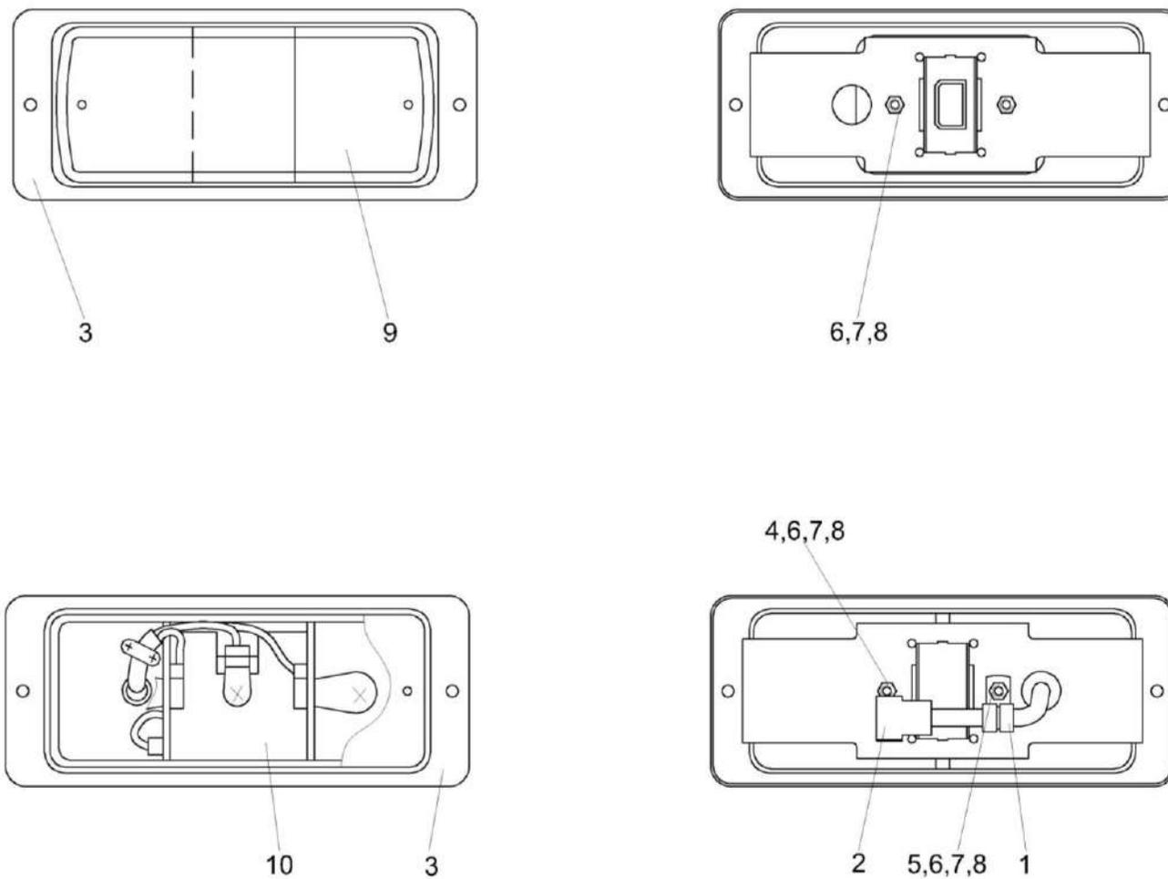
Рисунок 169 – Фонарь передний УЭС 0700930 и УЭС 0700930-02
