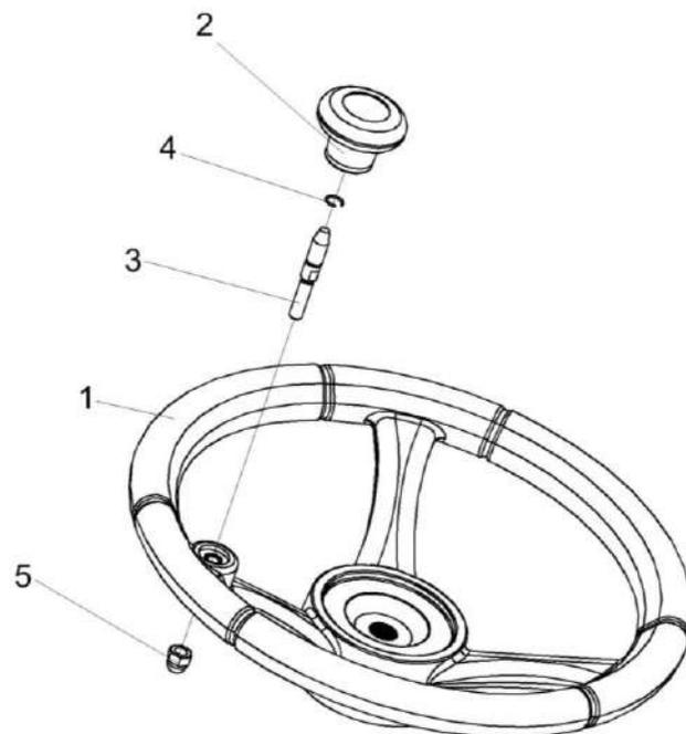
Рисунок 89 – Колесо рулевое КЗК-12-0122300
