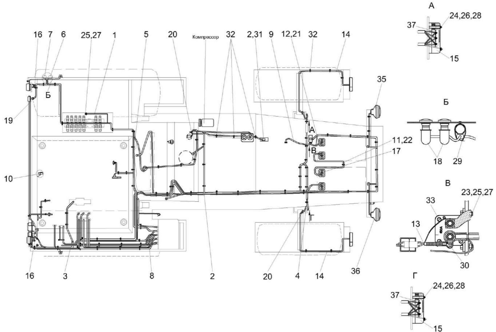
Рисунок 166 – Установка электрооборудования УЭС-6-2-0721000 (вид сверху)
