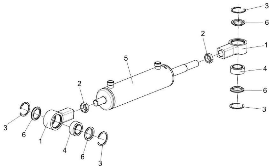
Рисунок 49 – Гидроцилиндр УЭС-7-0109200-01
