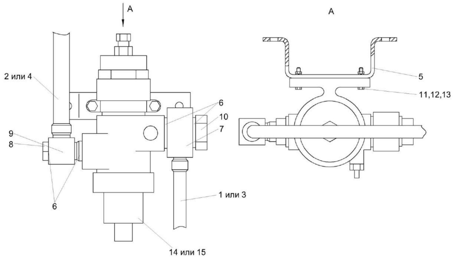
Рисунок 162 – Установка регуляторов давления УЭС-6-0800140 и УЭС-6-0800140-01
