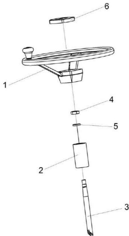
Рисунок 88 – Установка колеса рулевого КЗК-12-0122600
