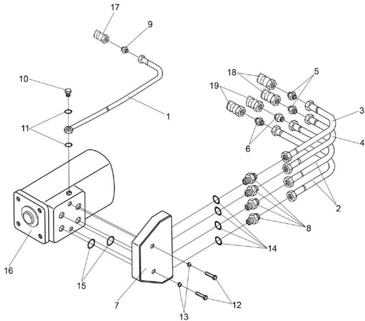
Рисунок 87 – Насос-дозатор УЭС-7-0603200
