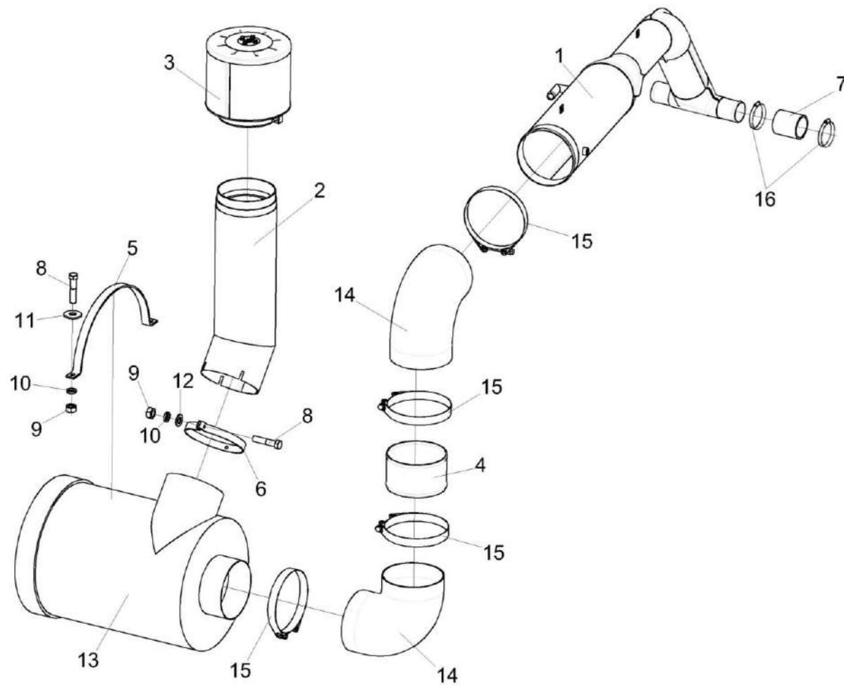
Рисунок 128 – Установка воздухоочистителя УЭС-6-1-0400080
