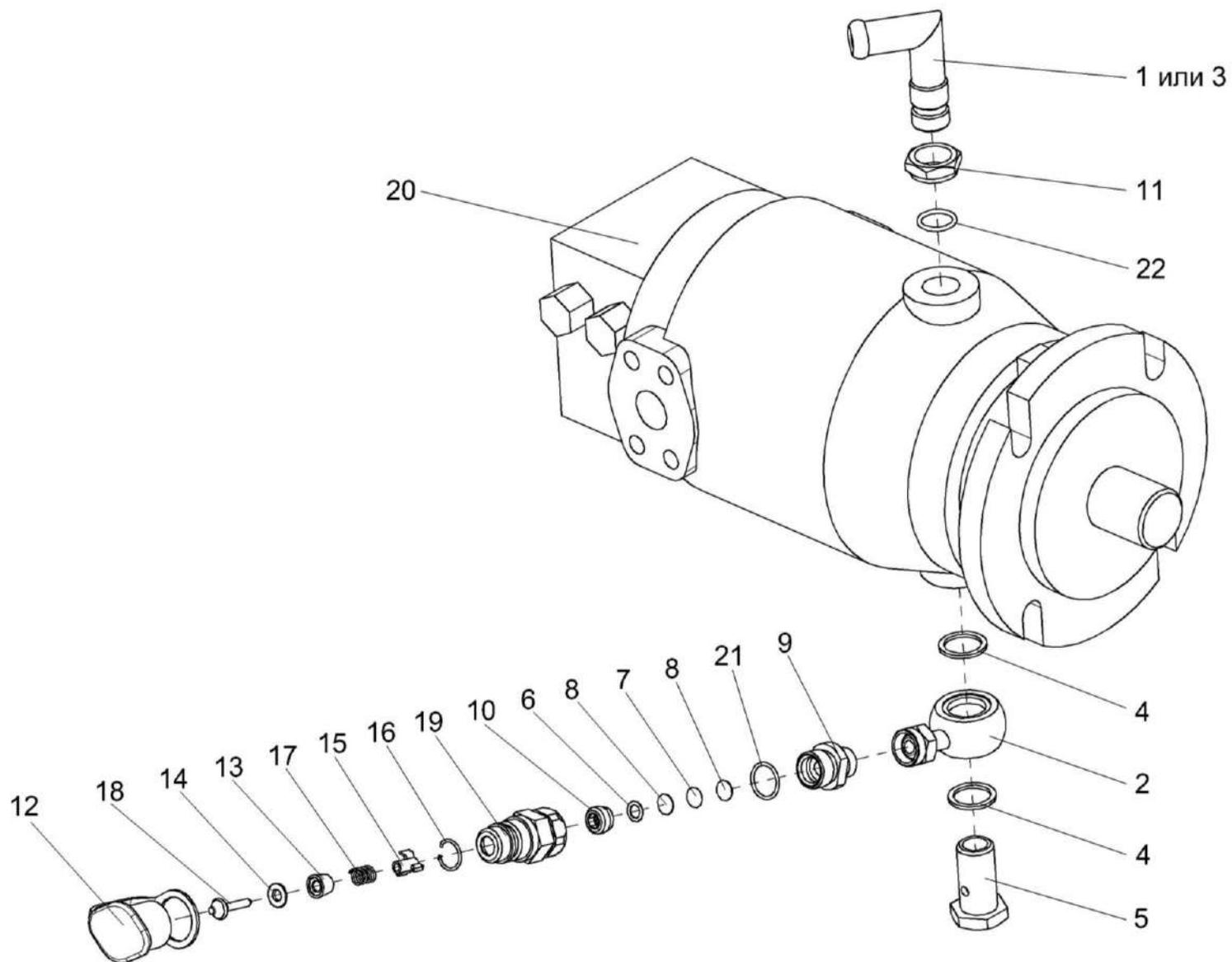
Рисунок 58 – Гидромотор УЭС-6-0601200
