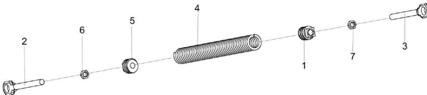
Рисунок 135 – Пружина КЗР 0202780А-02
