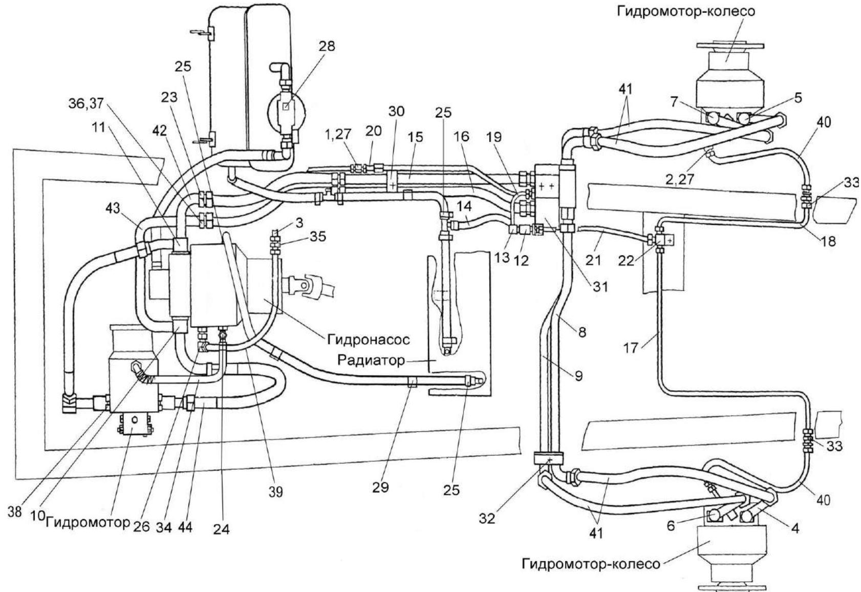
Рисунок 139 – Гидросистема привода ходовой части УЭС-6-0601000 (вид сверху)
