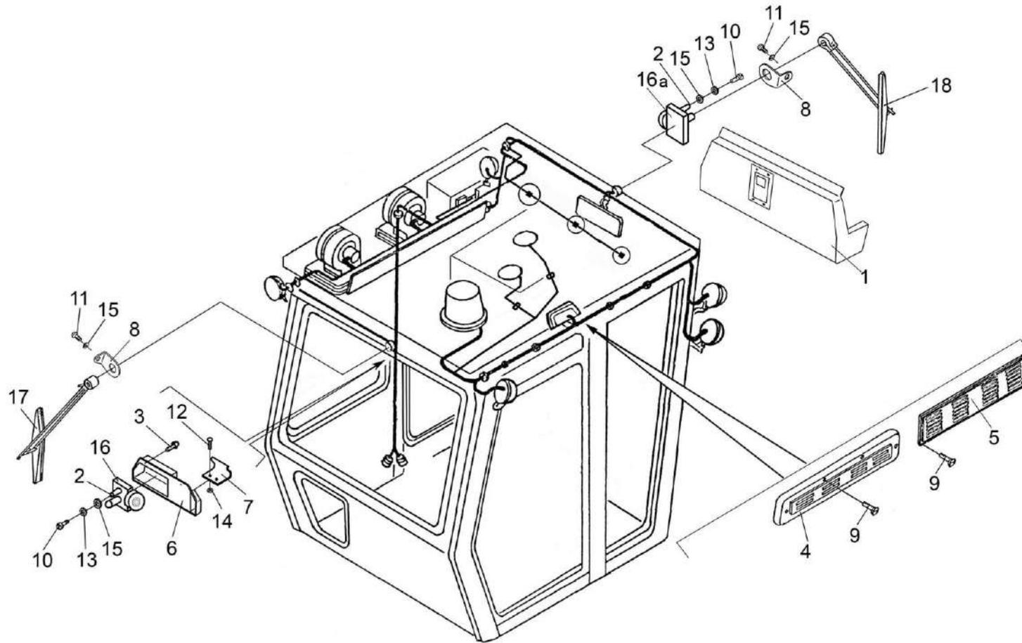
Рисунок 73 – Установка стеклоочистителя УЭС 0201450
