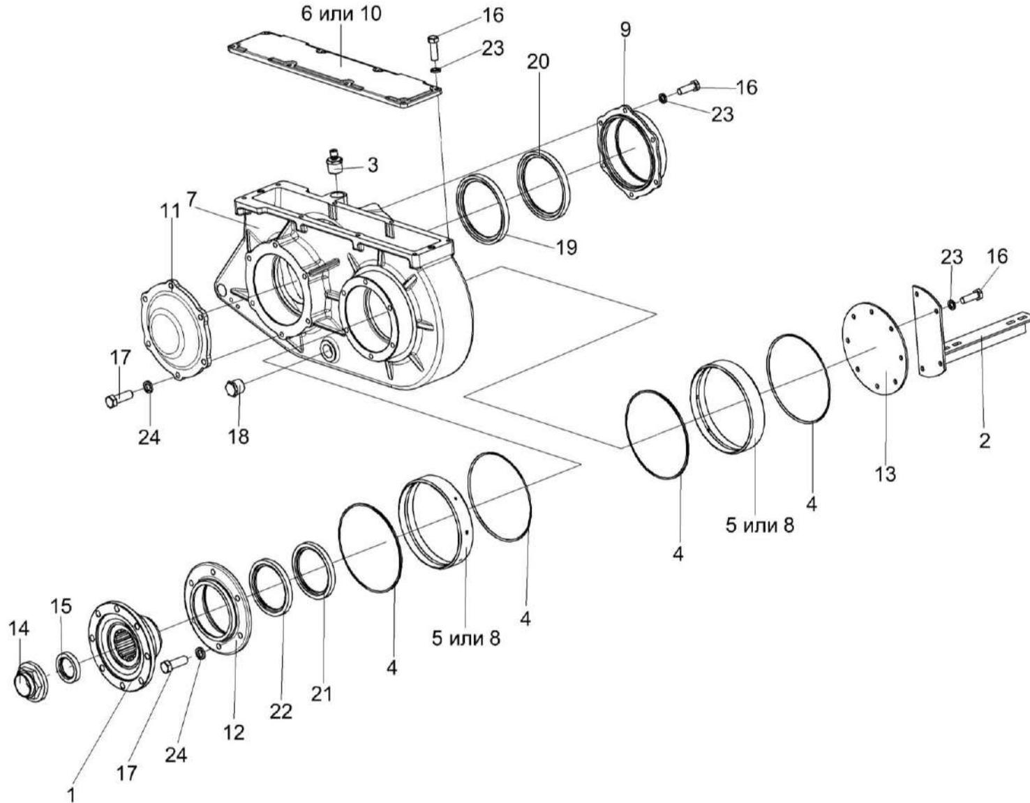
Рисунок 53 – Редуктор цилиндрический УЭС 0108000А (корпус, крышки)
