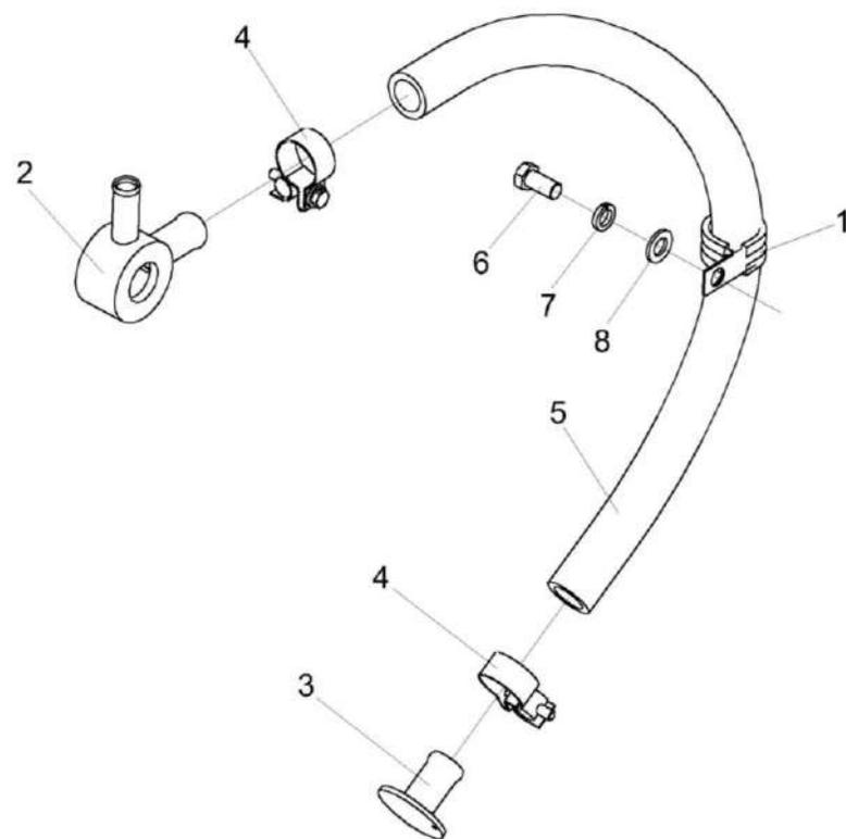
Рисунок 117 – Установка сливного рукава УЭС-6-1-0400120
