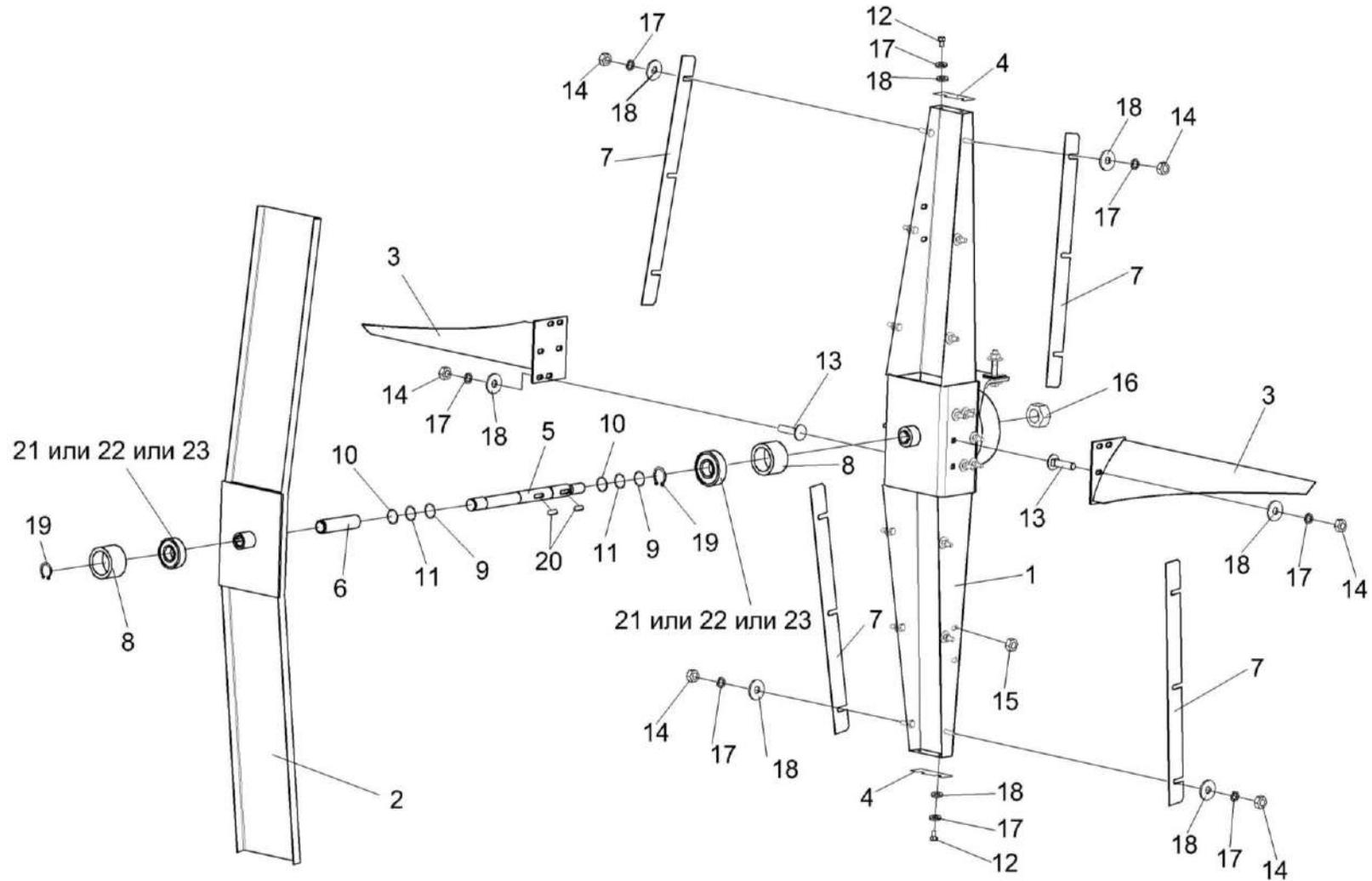
Рисунок 125 – Пылесъемник КЗК-12-3-0112130А
