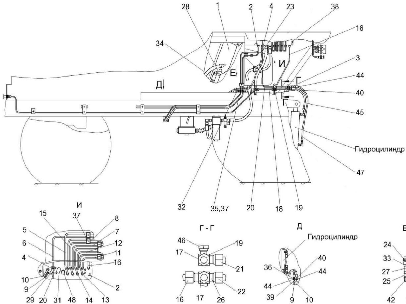
Рисунок 147 – Гидросистема рулевого управления и силовых гидроцилиндров УЭС-7-0602000-02 (лист 2)
