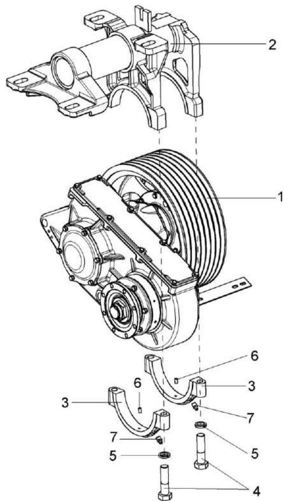
Рисунок 52 – Установка редуктора УЭС-7-0120000
