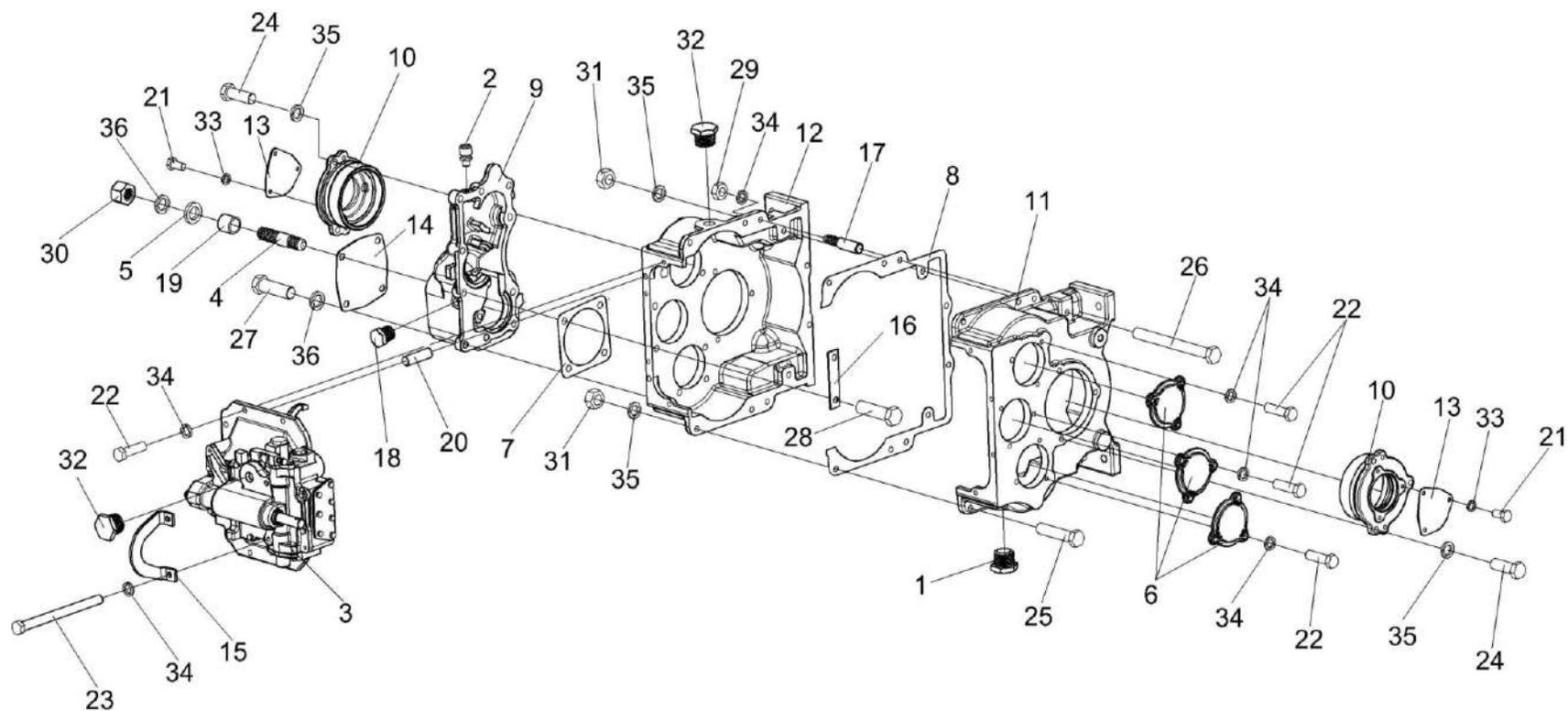
Рисунок 39 – Коробка диапазонов КЗК-8-0107530 (корпус, крышки)
