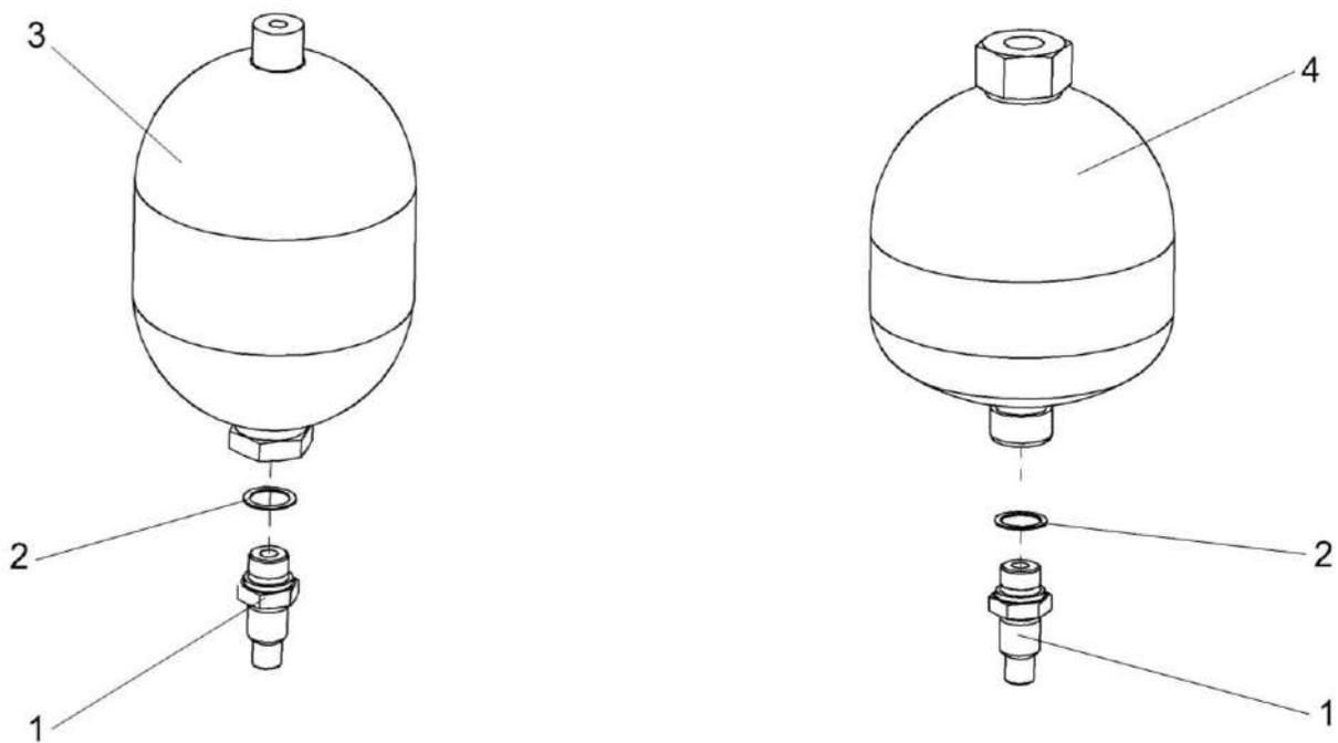
Рисунок 151 – Пневмогидроаккумулятор УЭС-7-0602470 и УЭС-7-0602470-02
