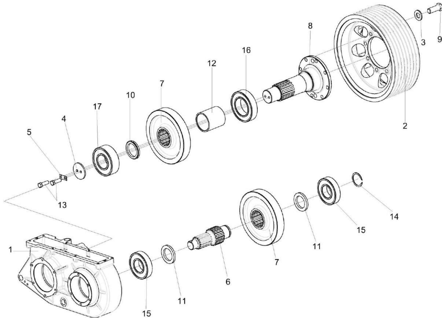
Рисунок 54 – Редуктор цилиндрический УЭС 0108000А (валы, шестерни)
