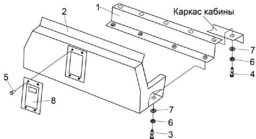
Рисунок 63 – Установка крышки УЭС-7-0200220-02 и уголка УЭС-7-0200070
