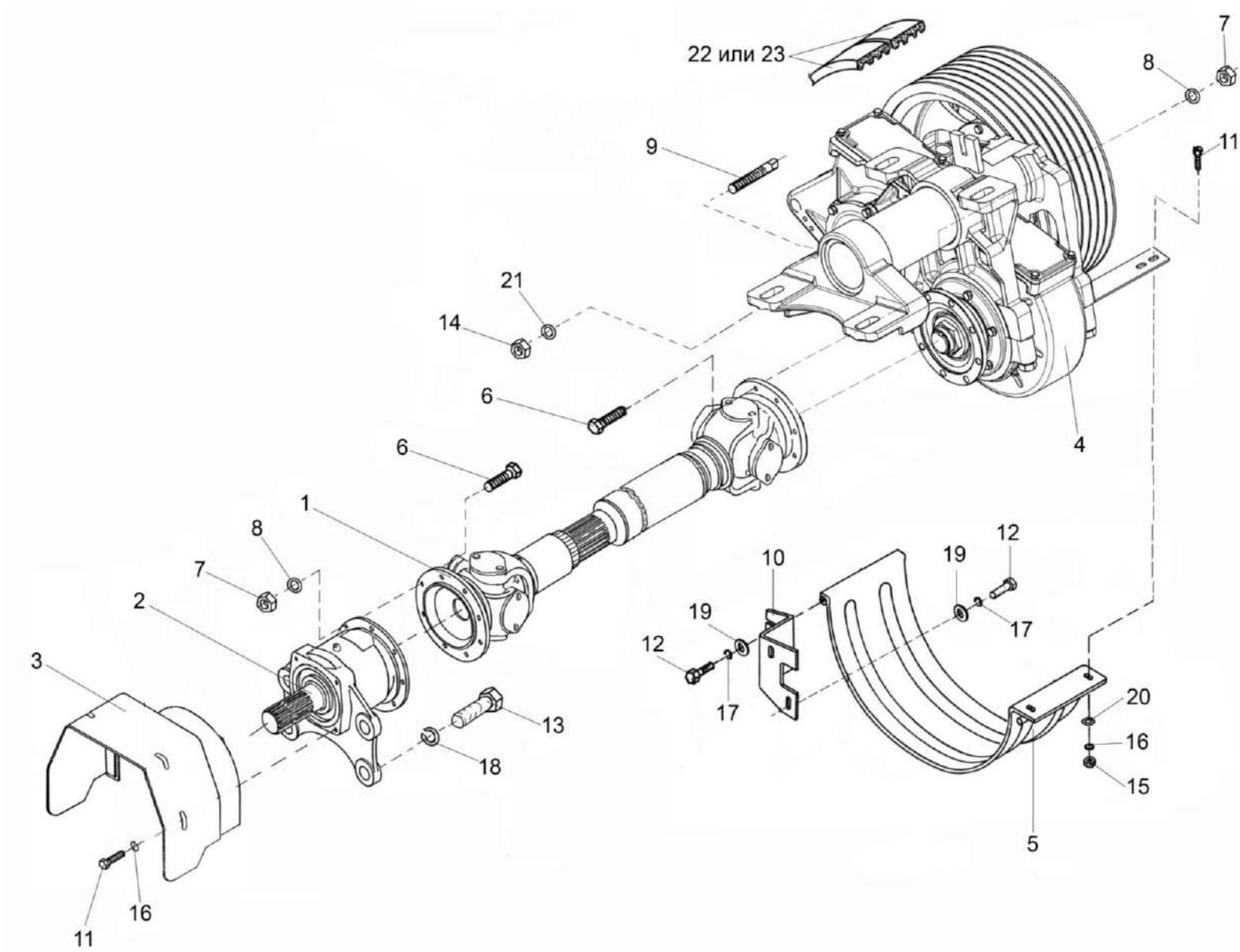
Рисунок 50 – Привод вала отбора мощности УМС 0115000
