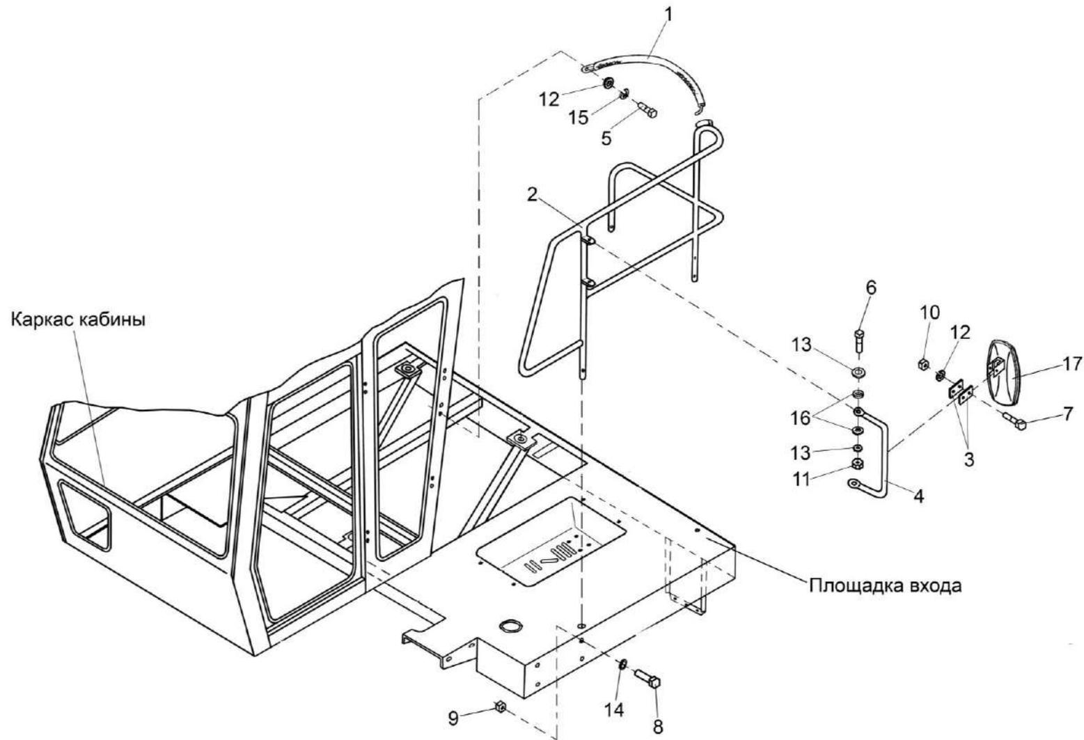
Рисунок 66 – Установка поручня УЭС-7-1000050
