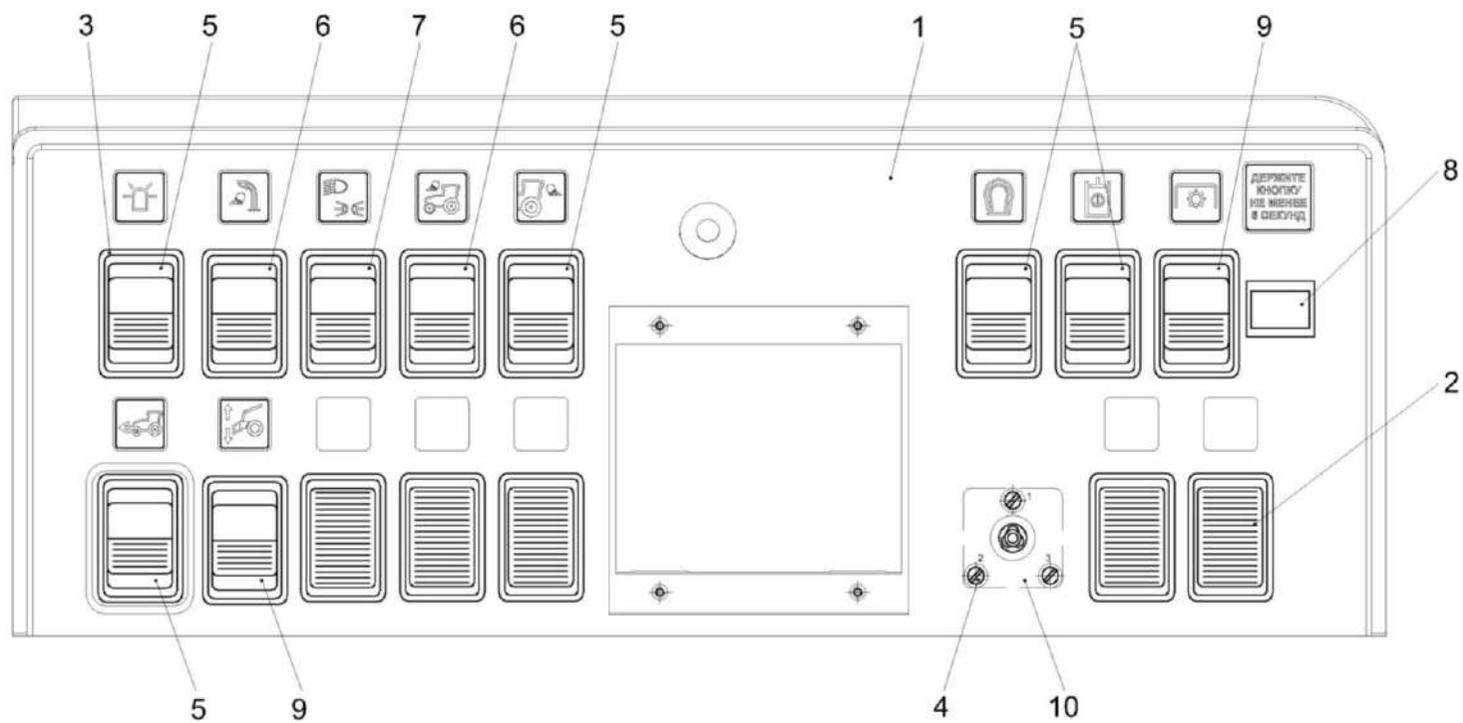
Рисунок 101 – Панель управления УЭС-6-2-0700450
