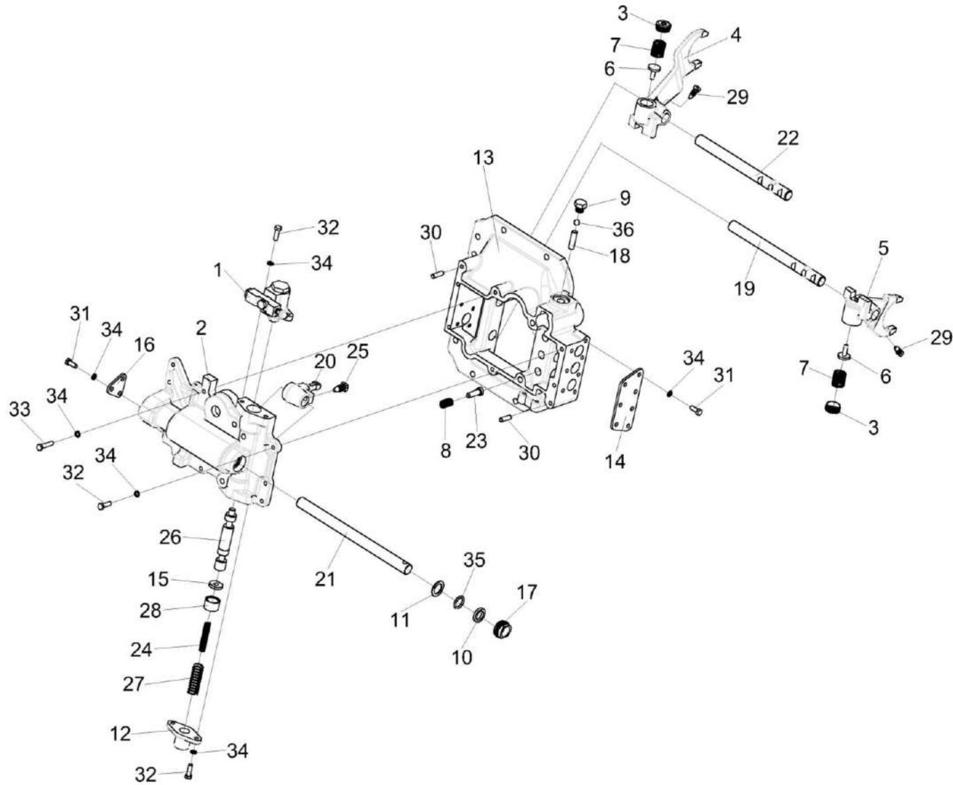
Рисунок 42 – Механизм переключения передач КЗК-8-0107560
