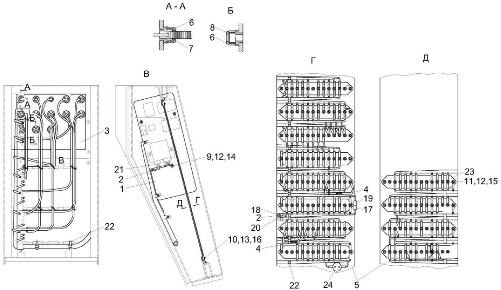
Рисунок 167 – Установка электрооборудования УЭС-6-2-0721000
