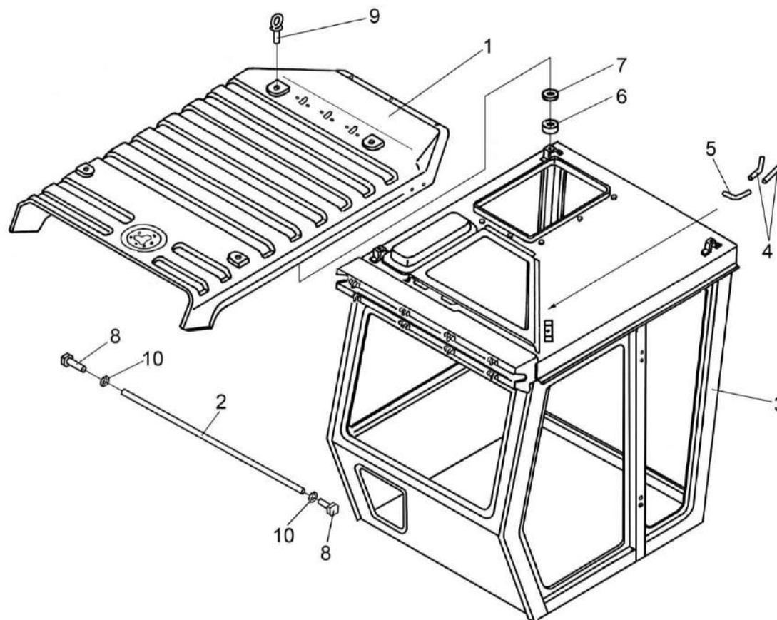
Рисунок 64 – Установка крыши УЭС 0201430
