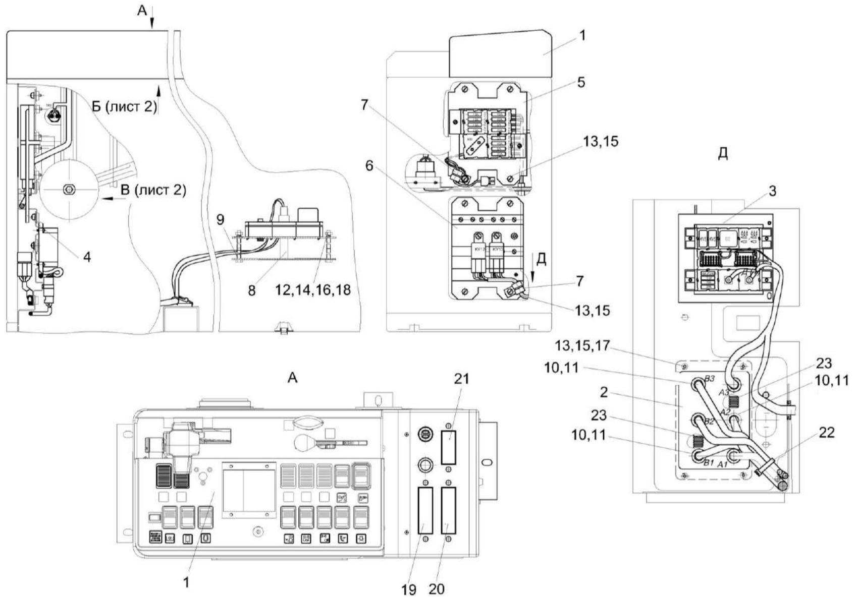
Рисунок 99 – Установка электрооборудования панели управления УЭС-6-2-0725000 (лист 1)
