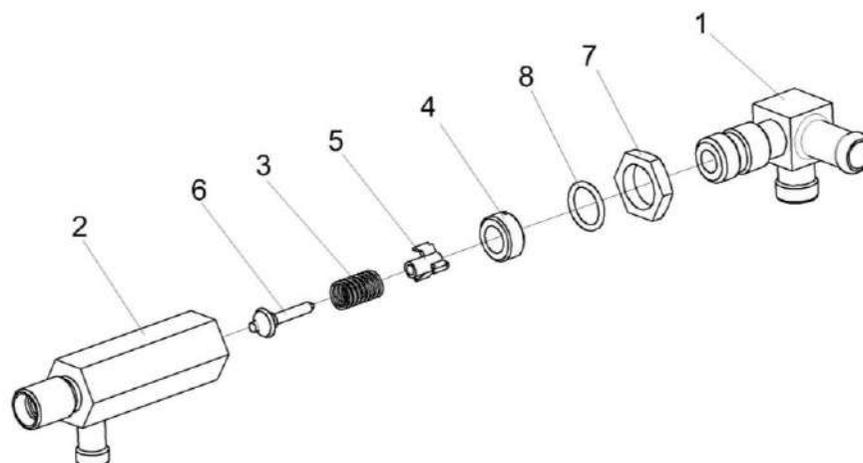
Рисунок 142 – Клапан дренажный УЭС-2-0605060
