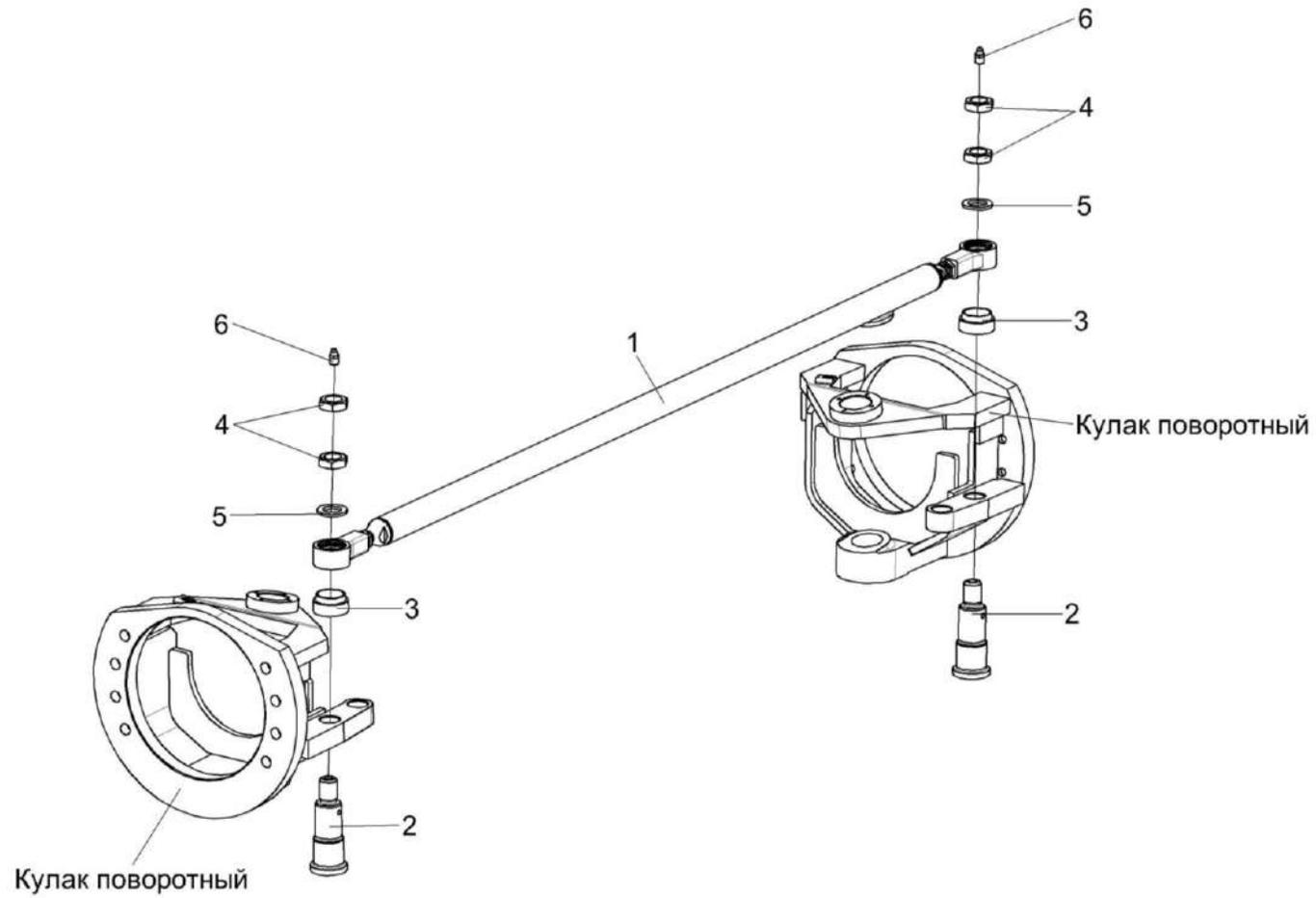
Рисунок 46 – Мост управляемых колес УМС 0109000 (установка рулевой тяги)
