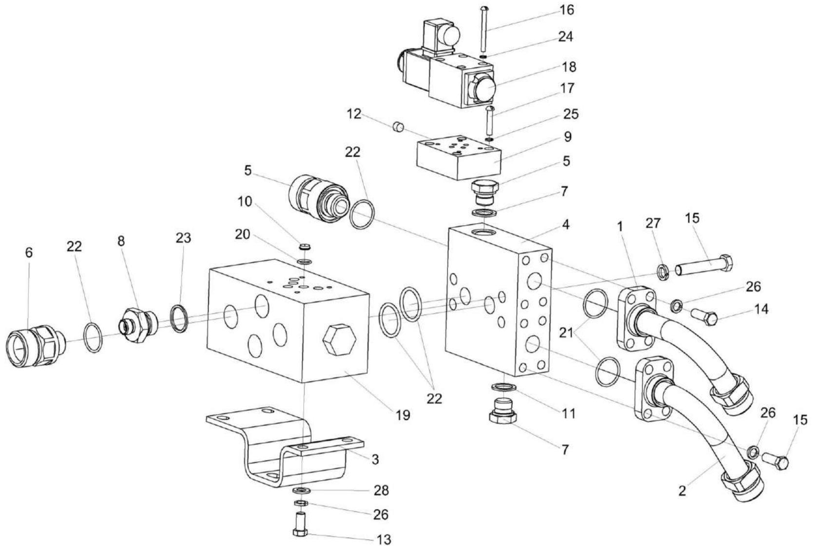
Рисунок 144 – Блок подключения управляемого моста УЭС-2-0605210
