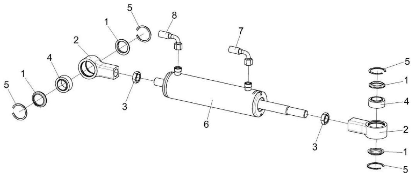
Рисунок 57 – Гидроцилиндр УЭС-7-0602950
