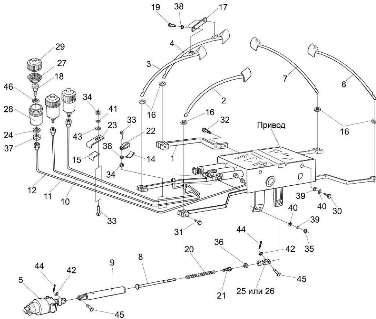
Рисунок 91 – Устройство тормозной системы
