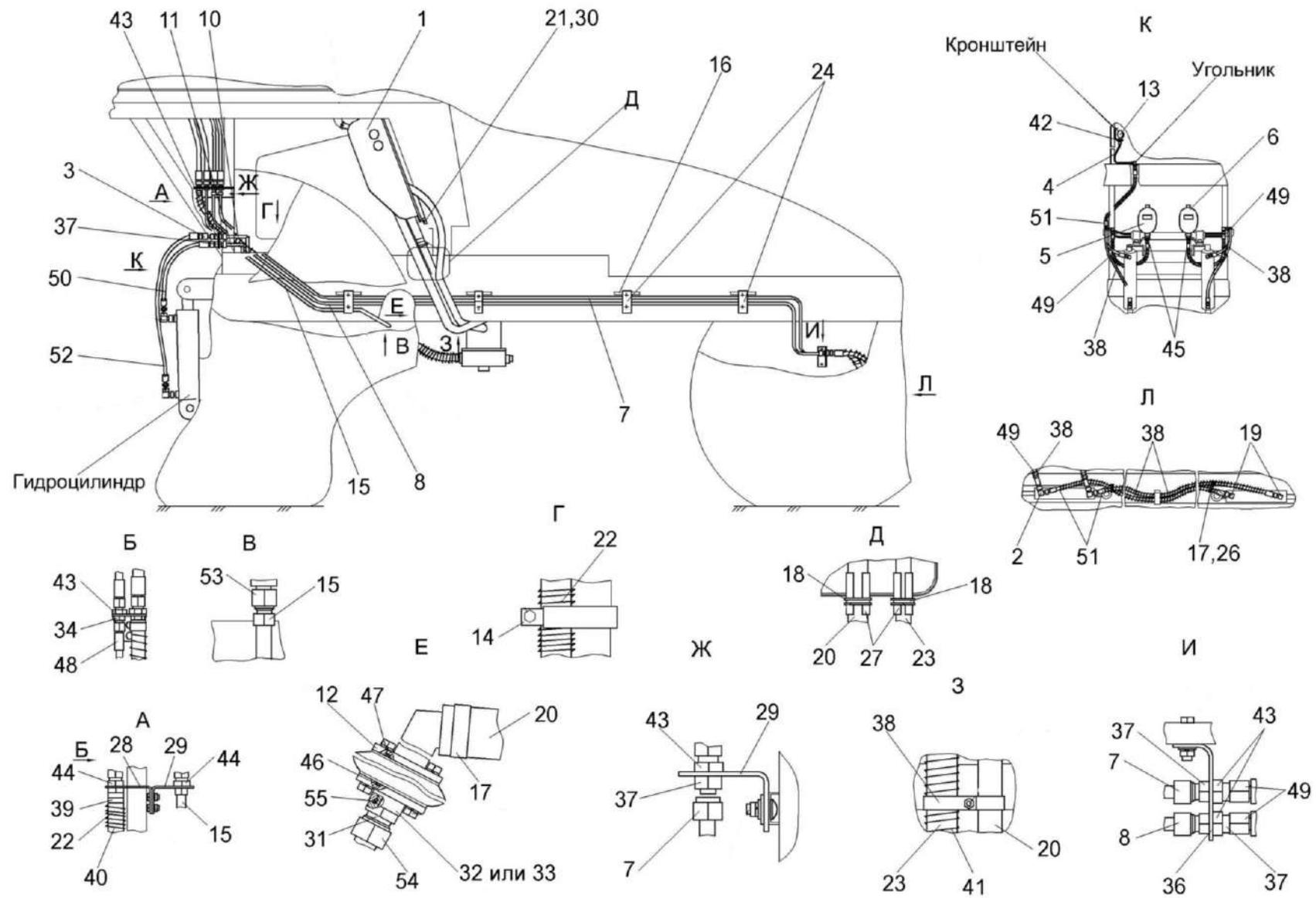
Рисунок 148 – Гидросистема рулевого управления и силовых гидроцилиндров УЭС-7-0602000-02 (лист 3)
