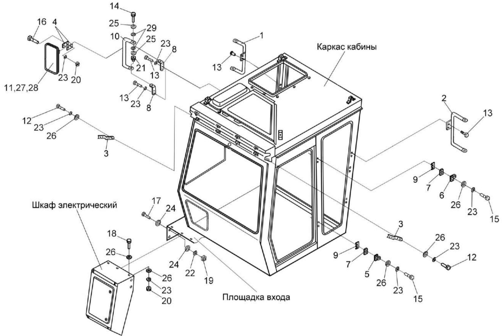
Рисунок 69 – Установка зеркал УЭС 0200720 и УЭС 0200720-01
