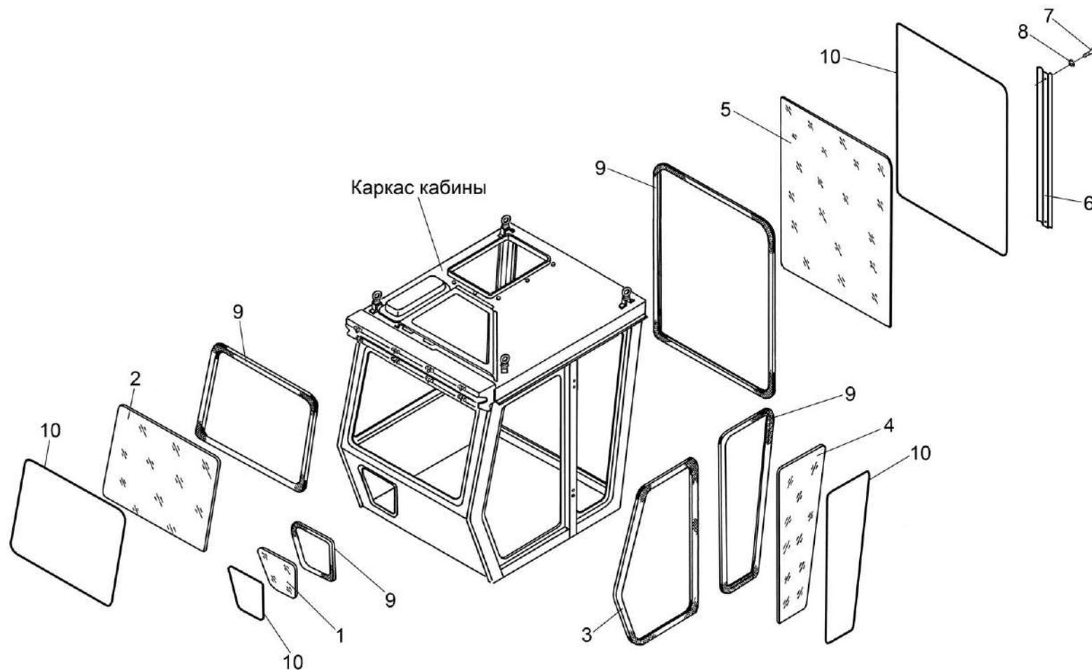
Рисунок 72 – Установка уплотнителей и стекол кабины
