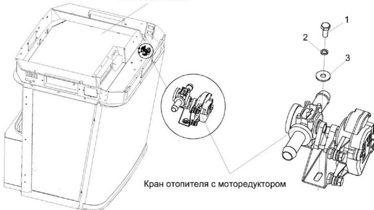
Кран отопителя с моторредуктором
