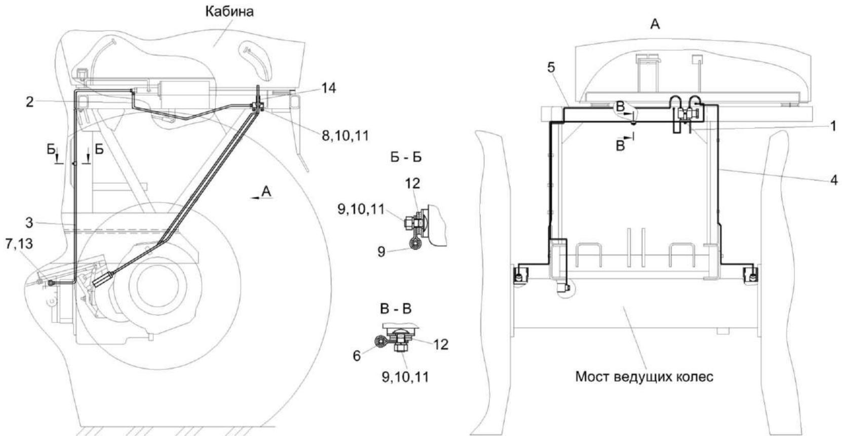
Рисунок 59 – Установка трубопроводов управления моста ведущих колес УЭС-7-0300600
