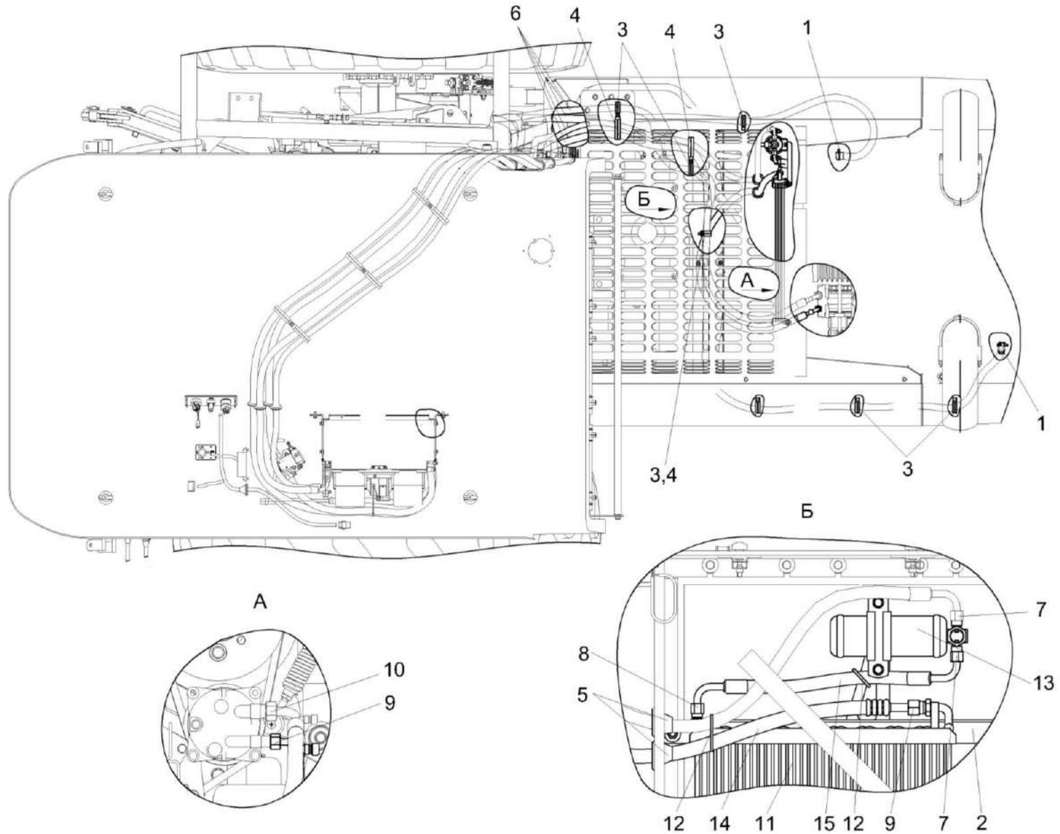
Рисунок 77 – Установка оборудования кондиционера УЭС-6-2-0151000
