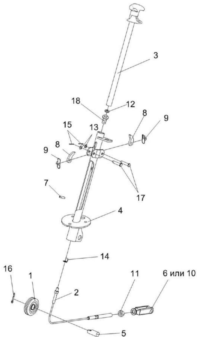
Рисунок 93 – Колонка привода УЭС 0300710
