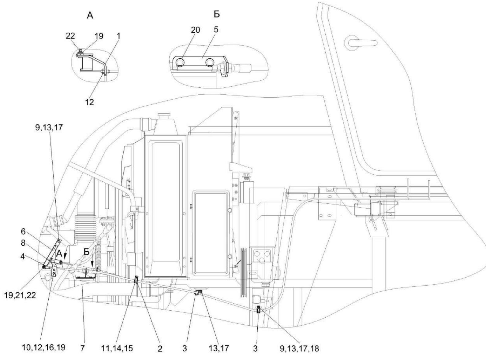
Рисунок 107 – Установка тросов управления двигателем УЭС-6-0300010
