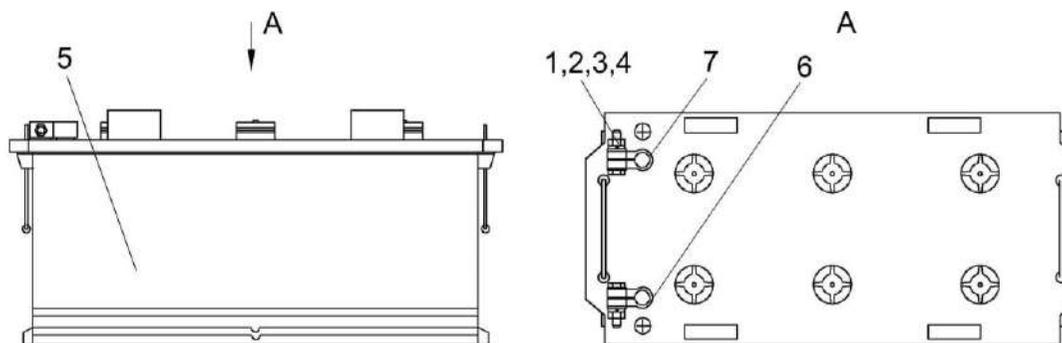
Рисунок 21 – Батарея аккумуляторная с переходниками КЗК 0705190
