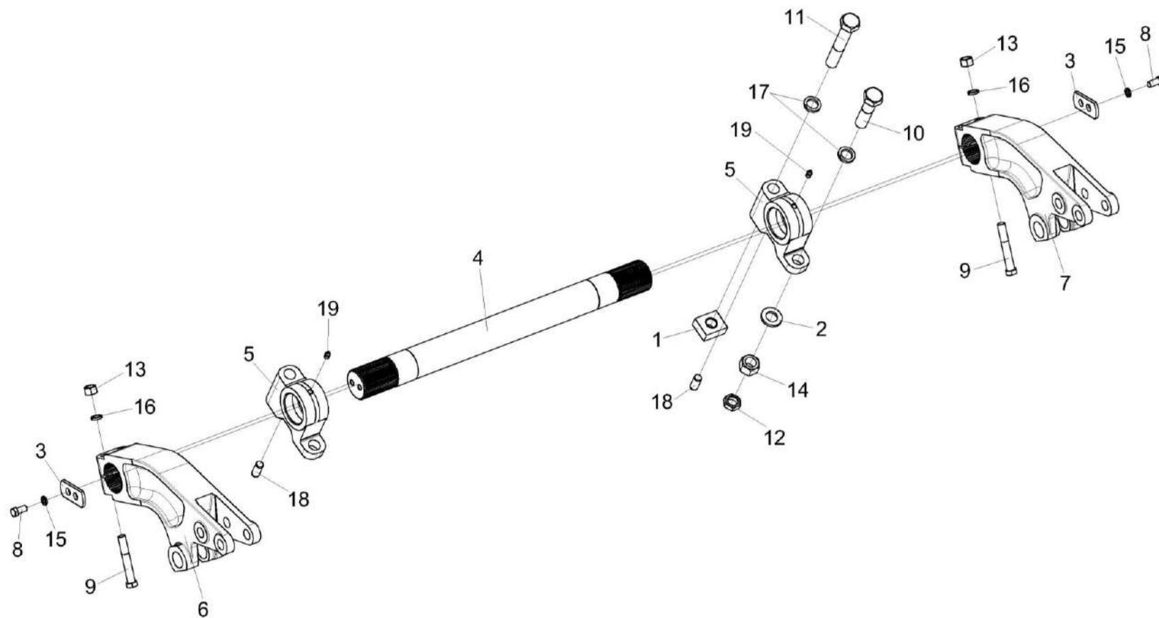
Рисунок 6 – Установка вала поворотного УЭС-7-0104020А
