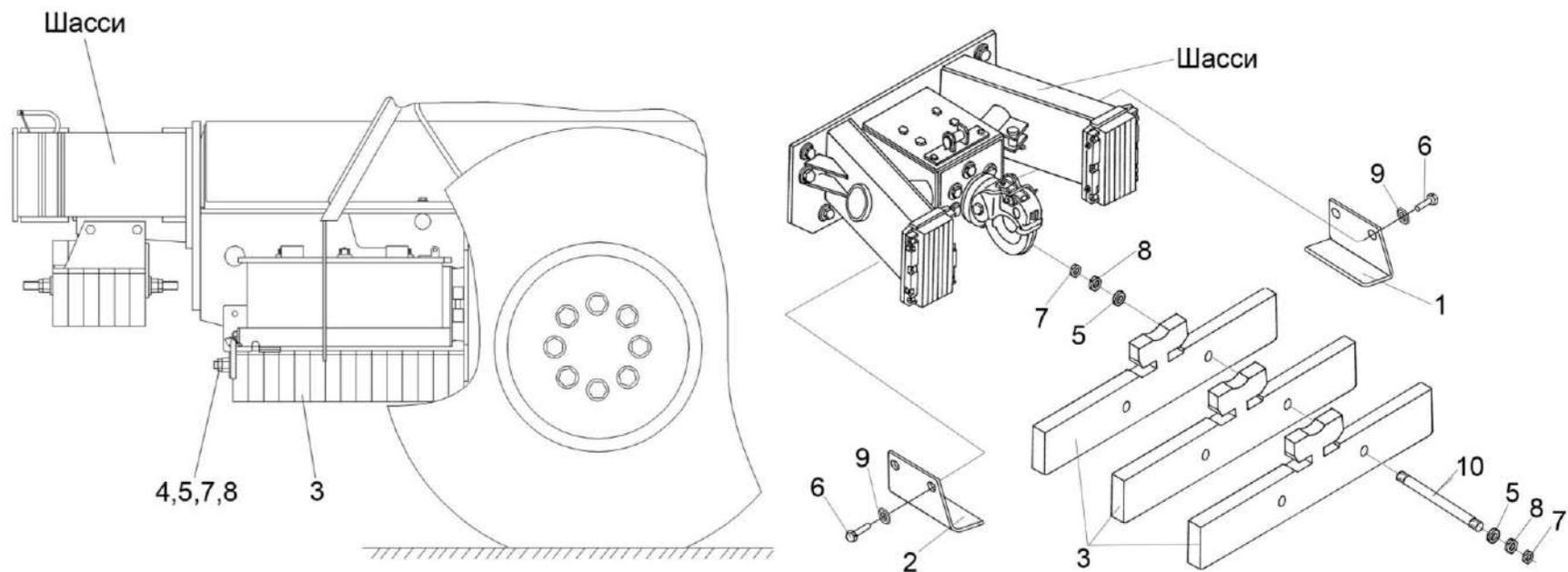
Рисунок 19 – Установка противовесов УЭС 000191Б-01
