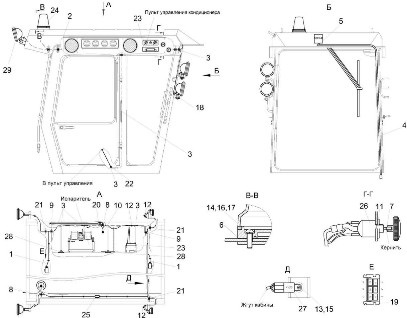
Рисунок 75 – Установка электрооборудования кабины УЭС-6-2-0722000
