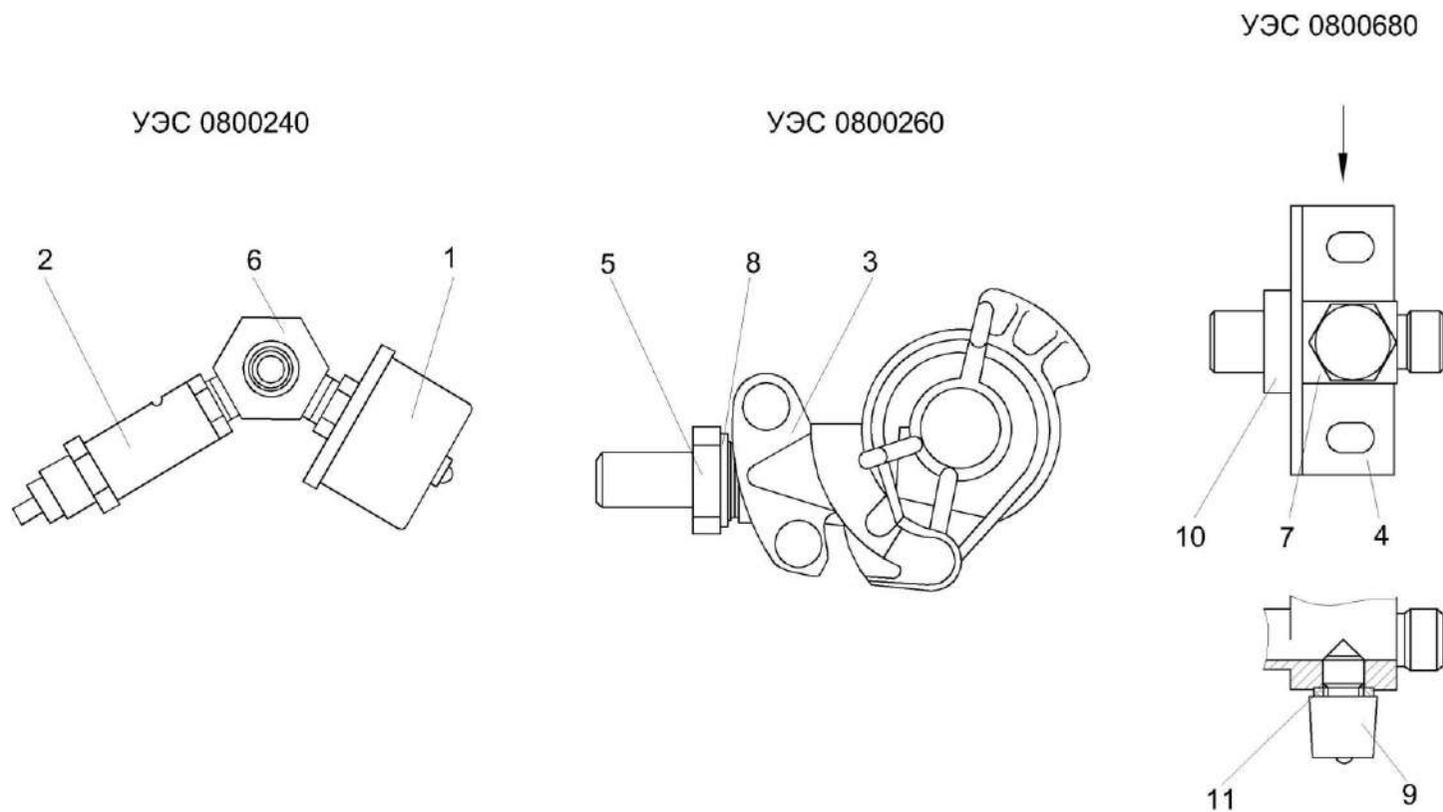
Рисунок 163 – Установка клапана УЭС 0800240, головка соединительная УЭС 0800260 и установка датчика УЭС 0800680
