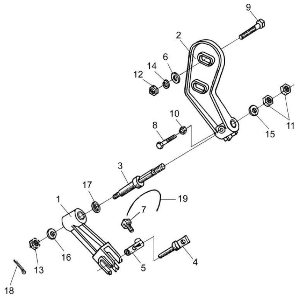
Рисунок 105 – Кронштейн УЭС 0300230-01 с рычагом УЭС 0300880-01 механизма переключения передач
