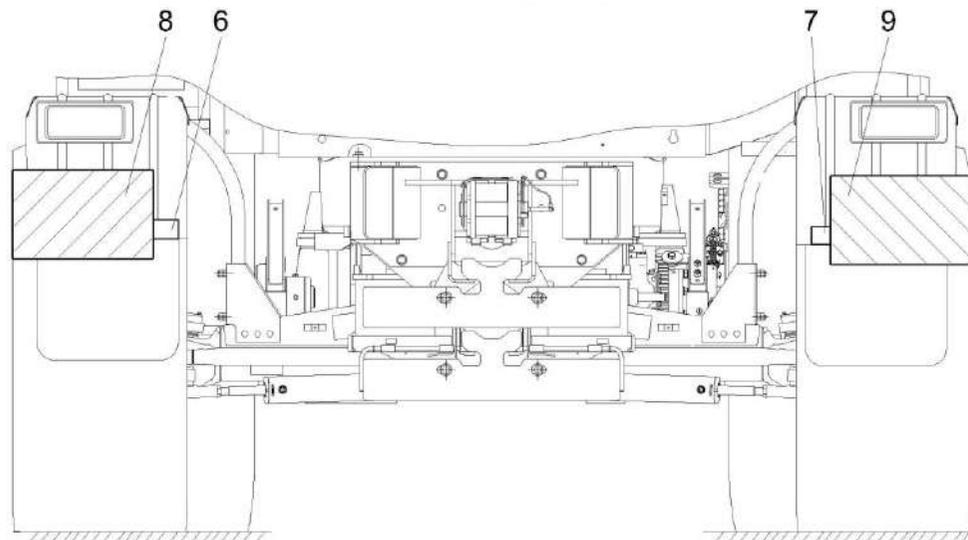
Рисунок 136 – Установка светоотражающих панелей УЭС-7-1001600
