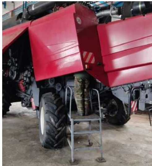
Рисунок 3.11 – Вид на лестничную площадку с оператором при замене сливного и напорного фильтроэлементов
