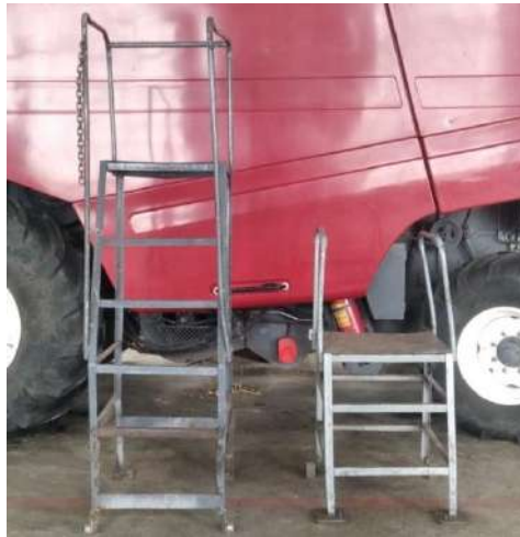
Рисунок 3.10 – Лестницы с площадкой
