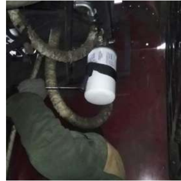
Рисунок 3.13 – Сливной фильтроэлемент, демонтируемый при помощи ключа фильтра
