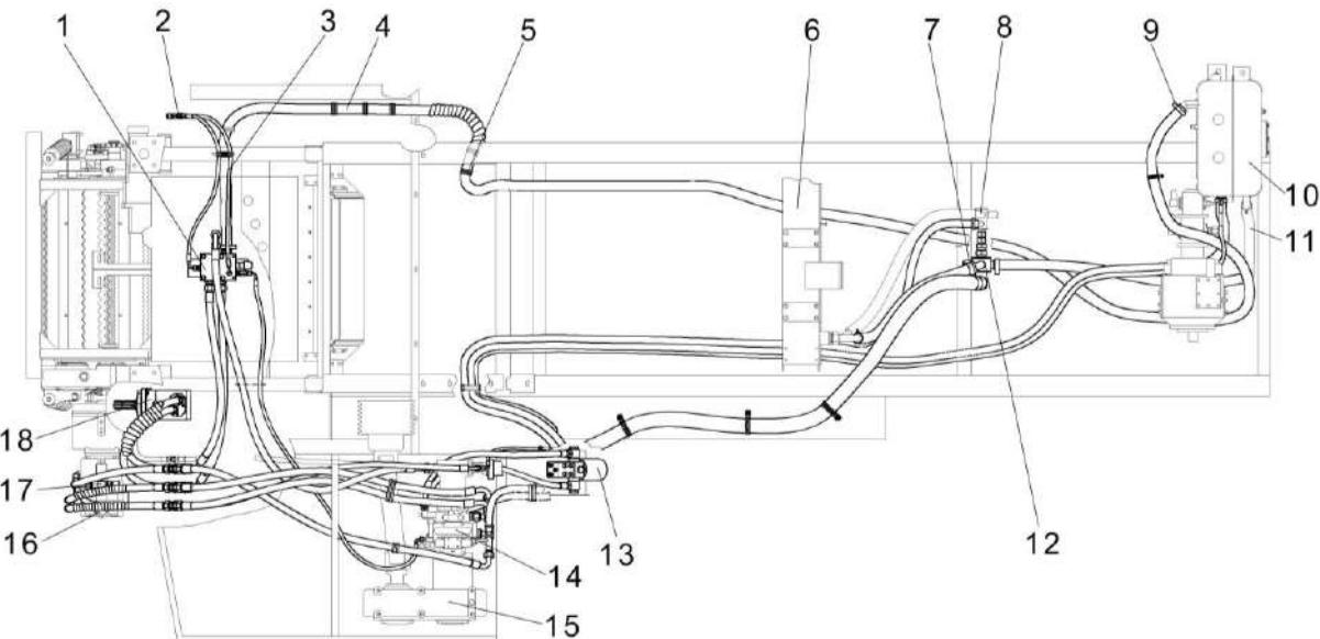
1 – гидроблок адаптеров; 2 – точки диагностики; 3, 4, 11 – рукава; 5, 7, 9 – хомуты; 6 – радиатор масляный; 8 – коллектор; 10 - бак масляный; 12 – клапан обратный; 13 – фильтр напорный; 14 – гидронасос двухсекционный; 15 – редуктор привода гидронасосов; 16 – гидромотор привода питающего аппарата с гидроблоком экстренного останова; 17 - полумуфта заправочная; 18 – гидромотор привода режущего аппарата
