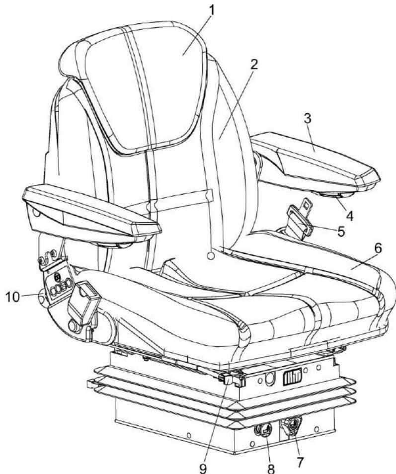
1 – подголовник; 2 – спинка; 3 – подлокотник; 4 – регулятор подлокотника по высоте; 5 – ремень безопасности; 6 – подушка сиденья; 7 – рычаг регулировки сиденья по высоте; 8 – кнопка регулировки системы подпрессоривания сиденья по массе оператора; 9 - рычаг фиксации продольного перемещения сиденья; 10 – рукоятка фиксации наклона спинки
