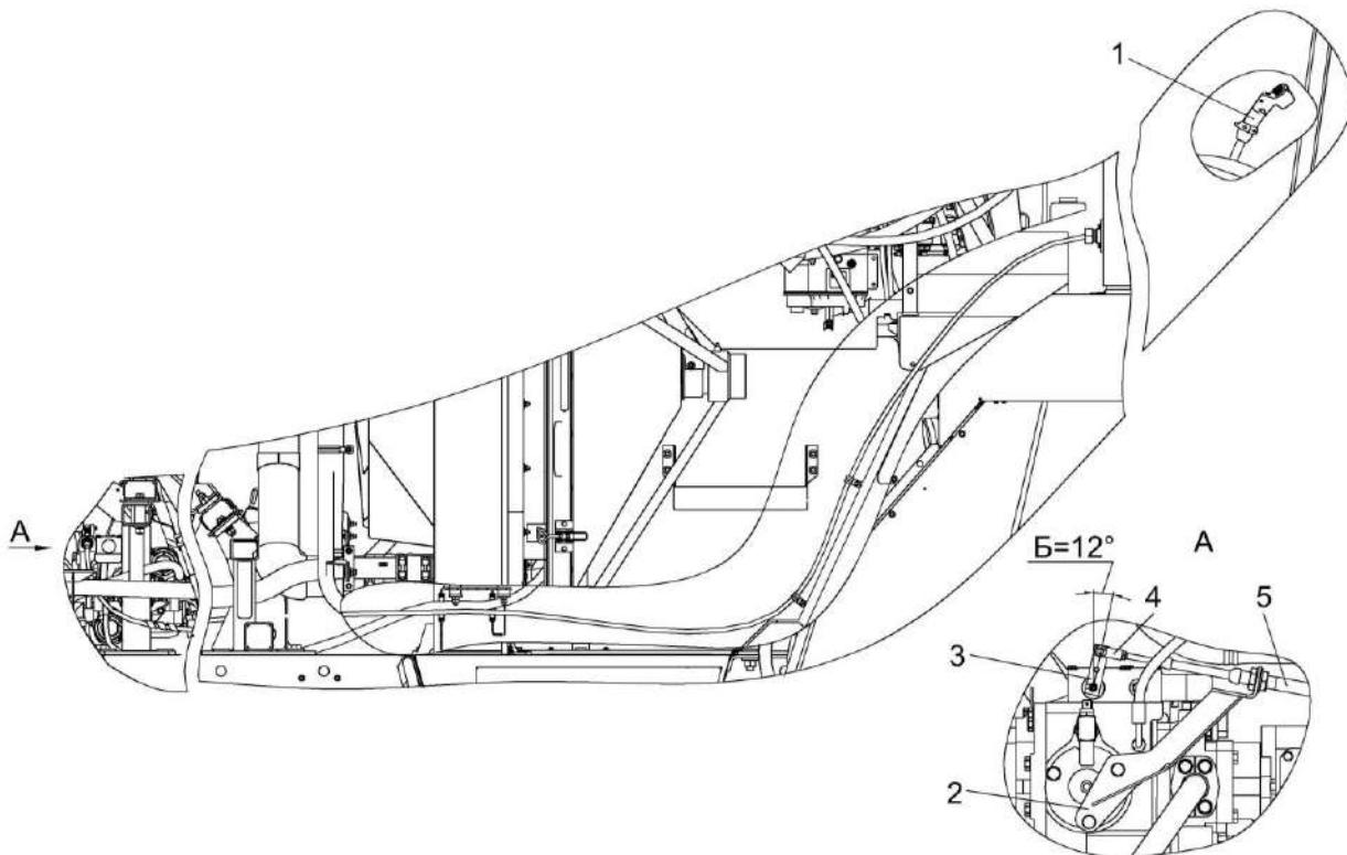
1 – рукоятка управления скоростью движения; 2 – кронштейн; 3 – флажок гидронасоса; 4 – ось; 5 – трос
