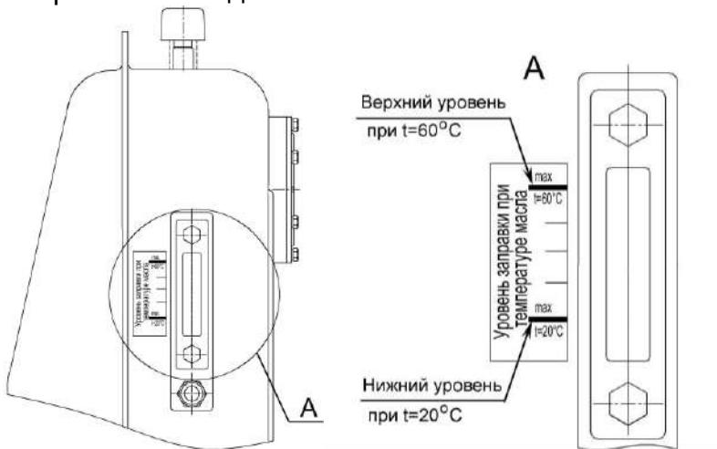
Рисунок 2.5 – Заправка гидросистем
