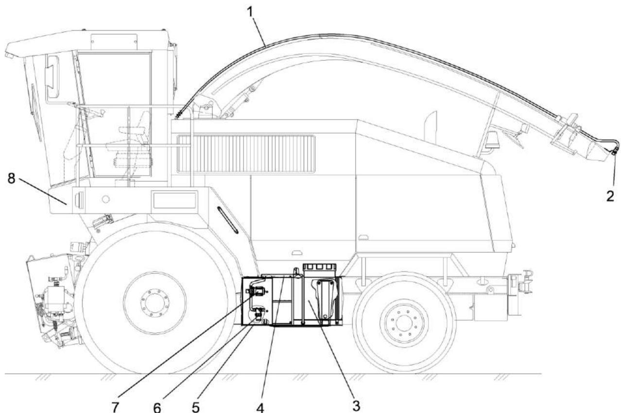
1 – электророжгут датчика наличия массы; 2 – датчик наличия массы; 3 – емкость для консерванта; 4 – площадка; 5 – рамка с ящиком для насоса; 6 – фильтр всасывающий; 7 – насос дозатор; 8 – комбайн
