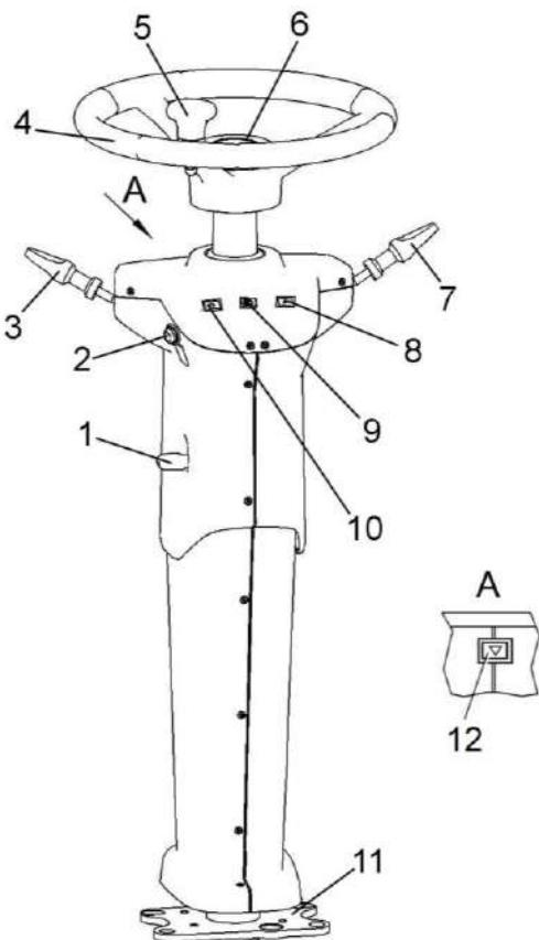
1 – ручка фиксации угла наклона колонки; 2 – выключатель звукового сигнала; 3 – переключатель световой сигнализации; 4 – колесо рулевое; 5 – ручка; 6 – крышка; 7 – переключатель стеклоочистителя; 8 – контрольная лампа включения правого поворота; 9 – контрольная лампа включения дальнего света; 10 – контрольная лампа включения левого поворота; 11 – кронштейн; 12- выключатель аварийной сигнализации
