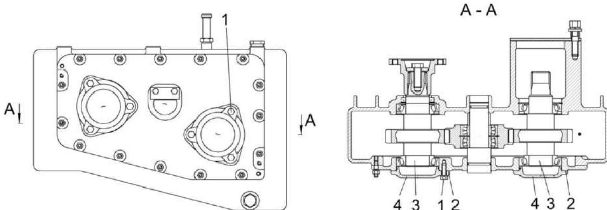
1 – болты; 2 - прокладки; 3 – вал-шестерня; 4 – крышка
