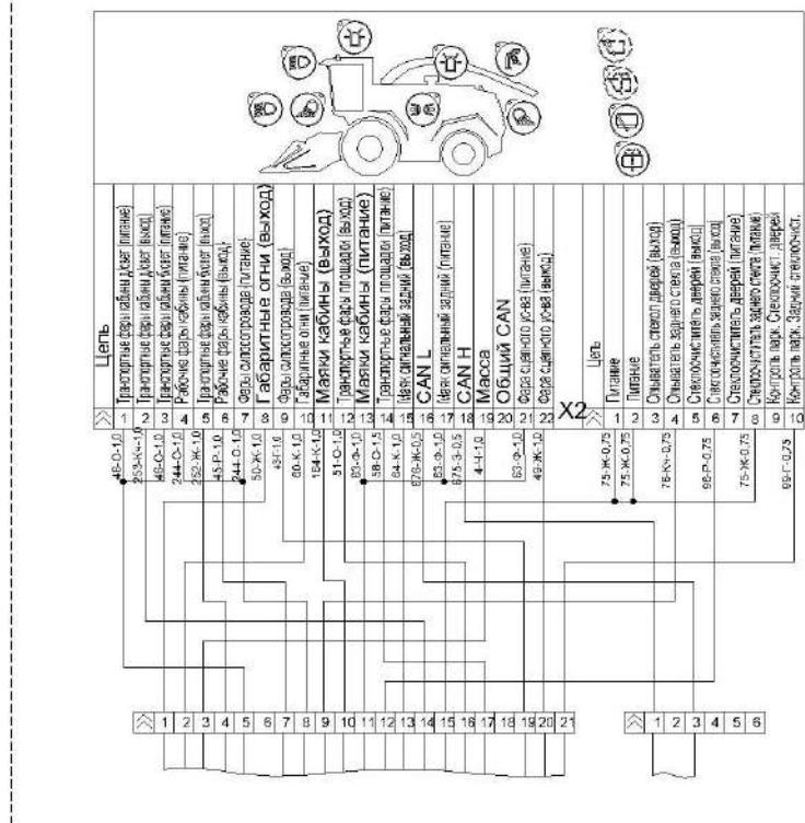
Рисунок Б.1 – Схема электрическая принципиальная комбайна (лист 3)
