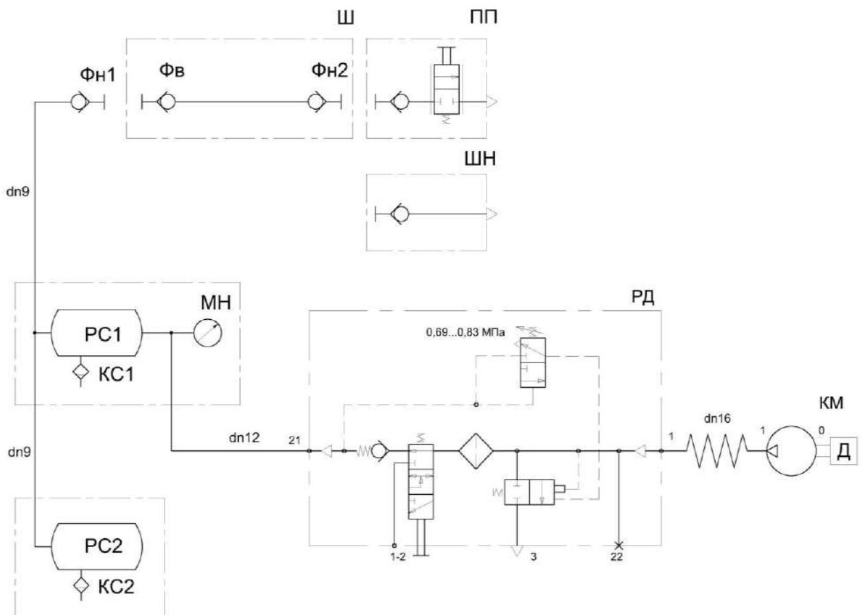
КМ – компрессор; КС1, КС2 – клапана слива конденсата; МН – манометр; ПП – пневмопистолет обдувочный; РД – регулятор давления; РС1, РС2 – ресиверы; Фв, Фн1, Фн2 – фитинги; Ш – шланг; ШН – шланг для накачивания шин
