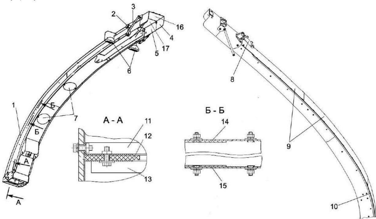
1 – силосопровод; 2 – датчик угла поворота; 3 – тяга; 4 – козырек; 5 – козырек средний; 6 – фары; 7 – люки; 8 – гидроцилиндр; 9 – крыши; 10 – крыша нижняя; 11 – опора; 12 – уплотнение; 13 – пластина; 14, 15 – накладки нижние; 16, 17 - накладки
