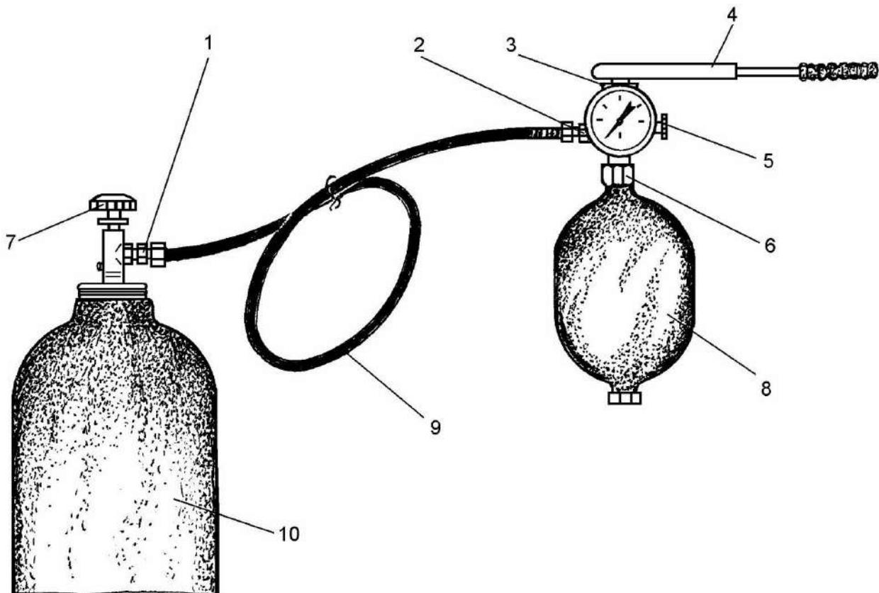
1 – переходник; 2 – обратный клапан зарядного устройства; 3 – зарядное устройство с манометром; 4 – динамометрический ключ с квадратной головкой  $\frac{1}{2}$ "; 5 – маховикок клапана для удаления газа; 6 – накидная гайка; 7 – маховикок запорного вентиля; 8 – пневмогидроаккумулятор; 9 – шланг; 10 – баллон с азотом
