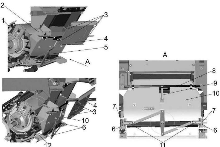
1 – барабан измельчающий; 2 – проставка; 3 – фиксаторы быстросъемные; 4 – стенка съемная; 5 – механизм открытия приемной камеры; 6 – направляющие; 7 – фиксаторы; 8 – ось; 9 – рычаг; 10 – приемная камера; 11 – втулки; 12 – отверстия для фиксации
