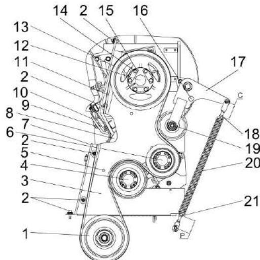
1 – ролик; 2 – фиксатор; 3 – панель; 4 – вал нижнего вальца; 5 – детали крепления (болты, гайки, шайбы) щитка 8; 6 – вал верхнего вальца; 7, 8 – щитки; 9, 14 – болты; 10 – скоба; 11 – ремень; 12 – вал ускорителя; 13 - шкив; 15 - пластина; 16 – фиксатор; 17 – рычаг; 18, 21 – контргайки; 19 – бонка; 20 - пружина
