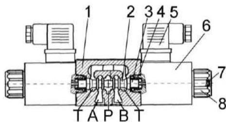
1 – корпус; 2 – золотник; 3 – толкатель; 4 – пружина; 5 – штепсельный разъем; 6 – катушка электромагнита; 7 – аварийная (контрольная) кнопка; 8 – гайка
