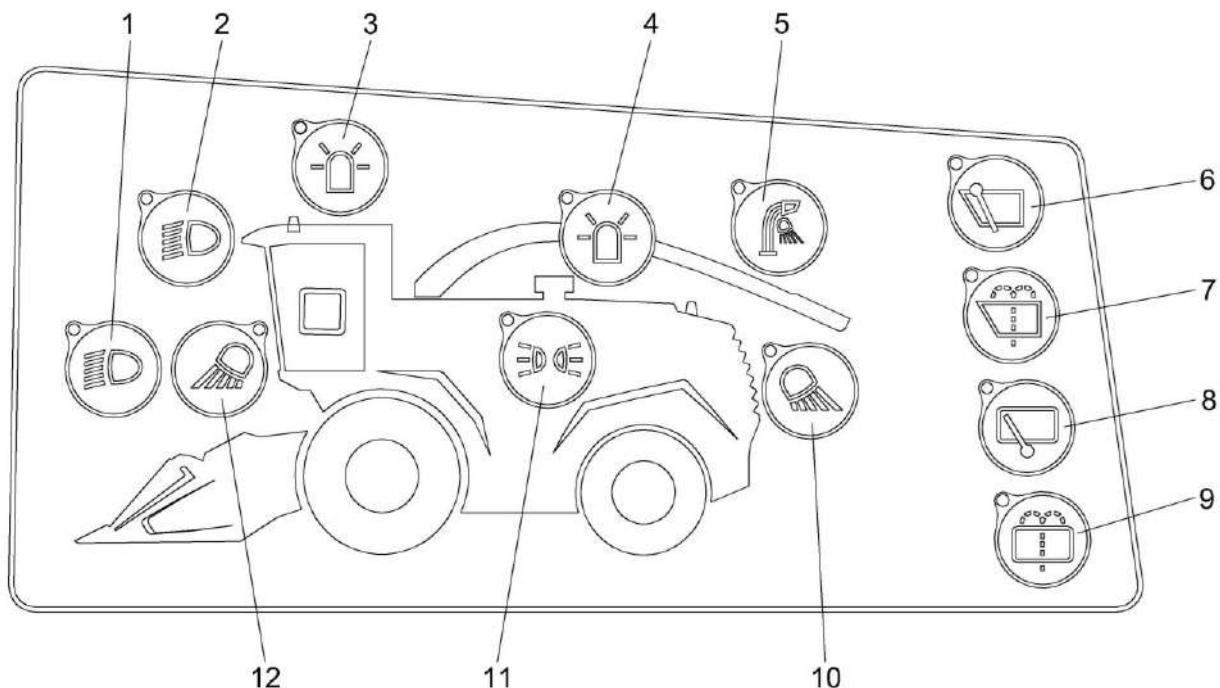
1 – выключатель ближнего света; 2 – выключатель передних рабочих фар (на кабине);
