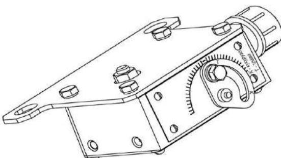
Рисунок 2.6 – Датчик камнедетектора
