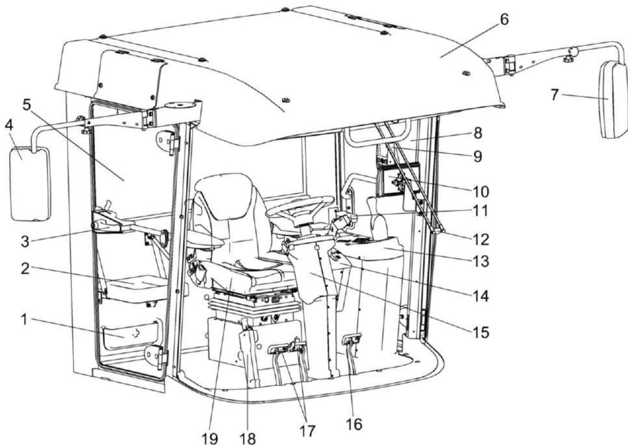
1 – место установки аптечки; 2 – дополнительное сиденье; 3 – замок двери; 4, 7 – зеркала заднего вида; 5 – дверь; 6 – крыша; 8 – дверь аварийного выхода; 9 – пульт АСОТП; 10 – терминал многофункциональный; 11 – ручка; 12 – стеклоочиститель; 13 – пульт управления; 14 – блок управления; 15 – рулевая колонка; 16 – педаль блокировки коробки передач; 17 – тормозные педали; 18 – стояночный тормоз; 19 – сиденье оператора
