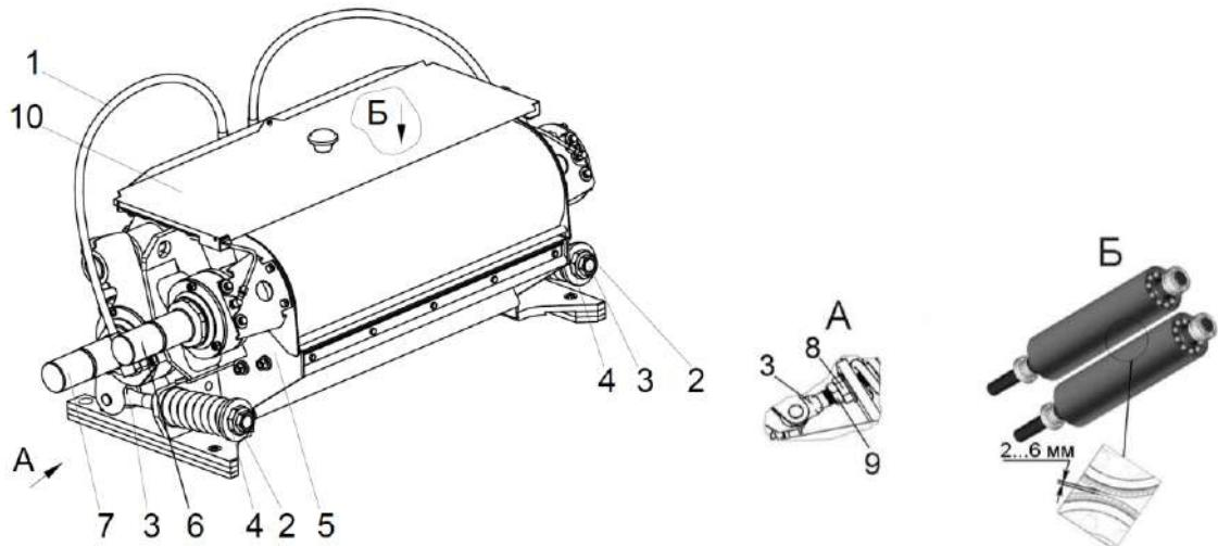
1 – гидросистема регулировки зазора; 2, 9 – гайки; 3 – тяга; 4 – гильза; 5 – корпус; 6 – валец верхний; 7 – валец нижний; 8 – упор; 10 – крышка
