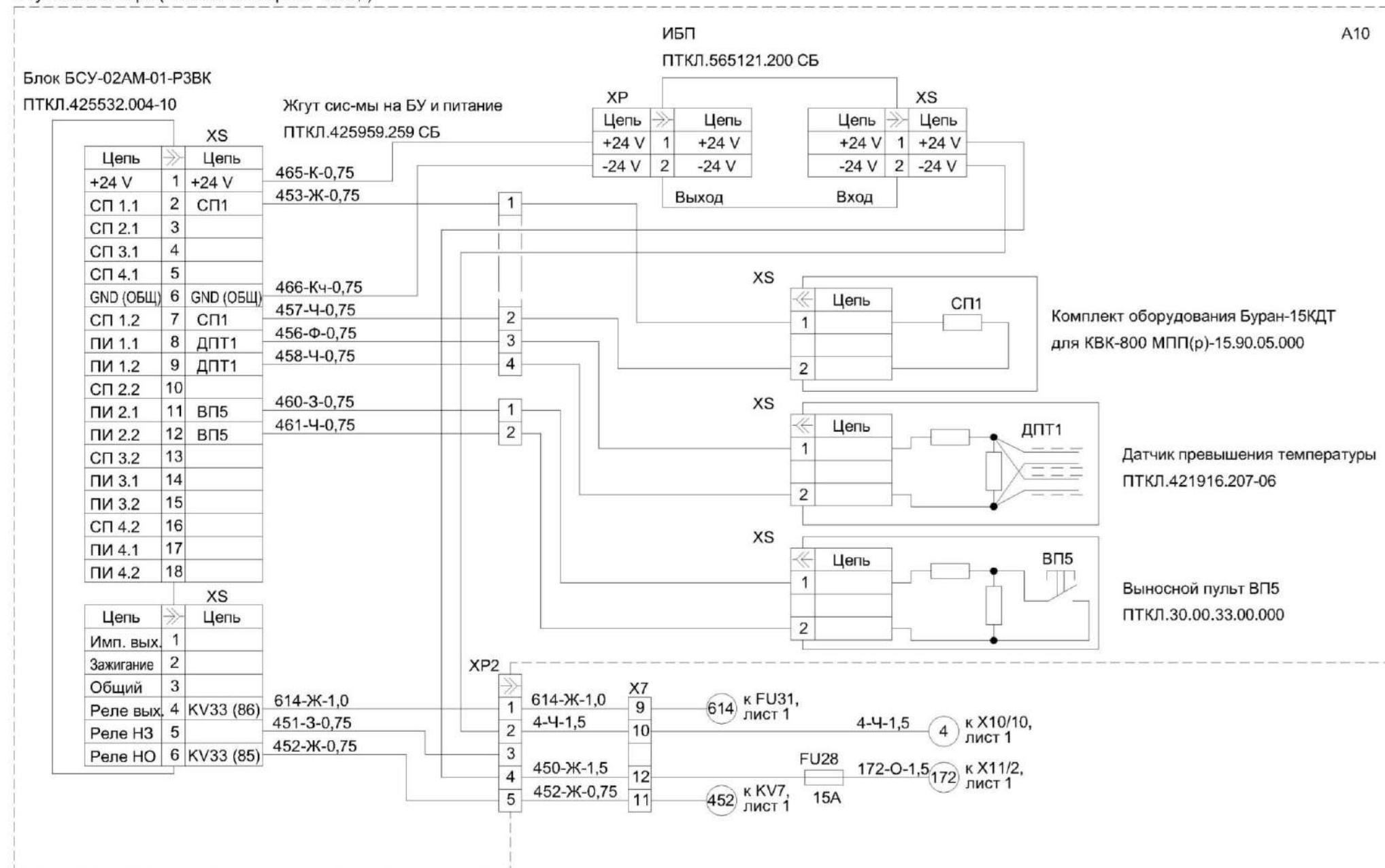
Рисунок Б.1 – Схема электрическая принципиальная комбайна (лист 7)
