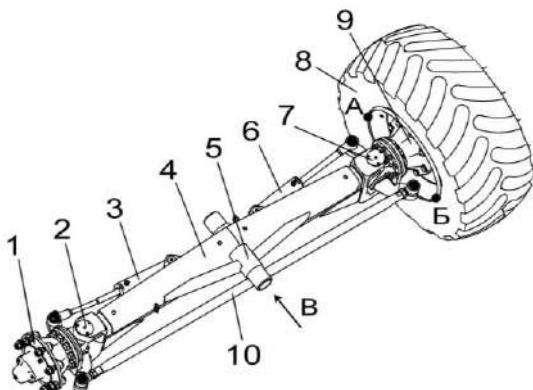
1, 9 – ступицы колес; 2, 7 – шкворни; 3, 6 – гидроцилиндры; 4 – балка моста; 5 – ось; 8 – колесо; 10 – тяга рулевая
