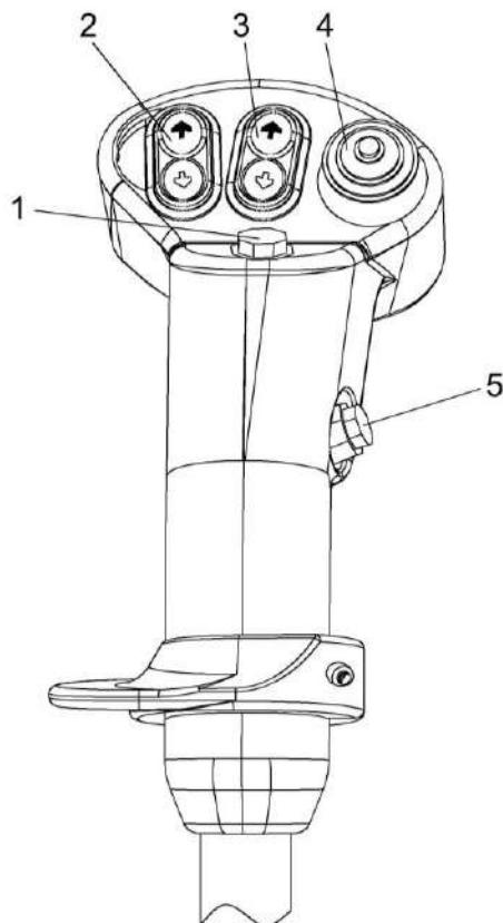
1 – кнопка звукового сигнала; 2 – переключатель управления питающим аппаратом;
