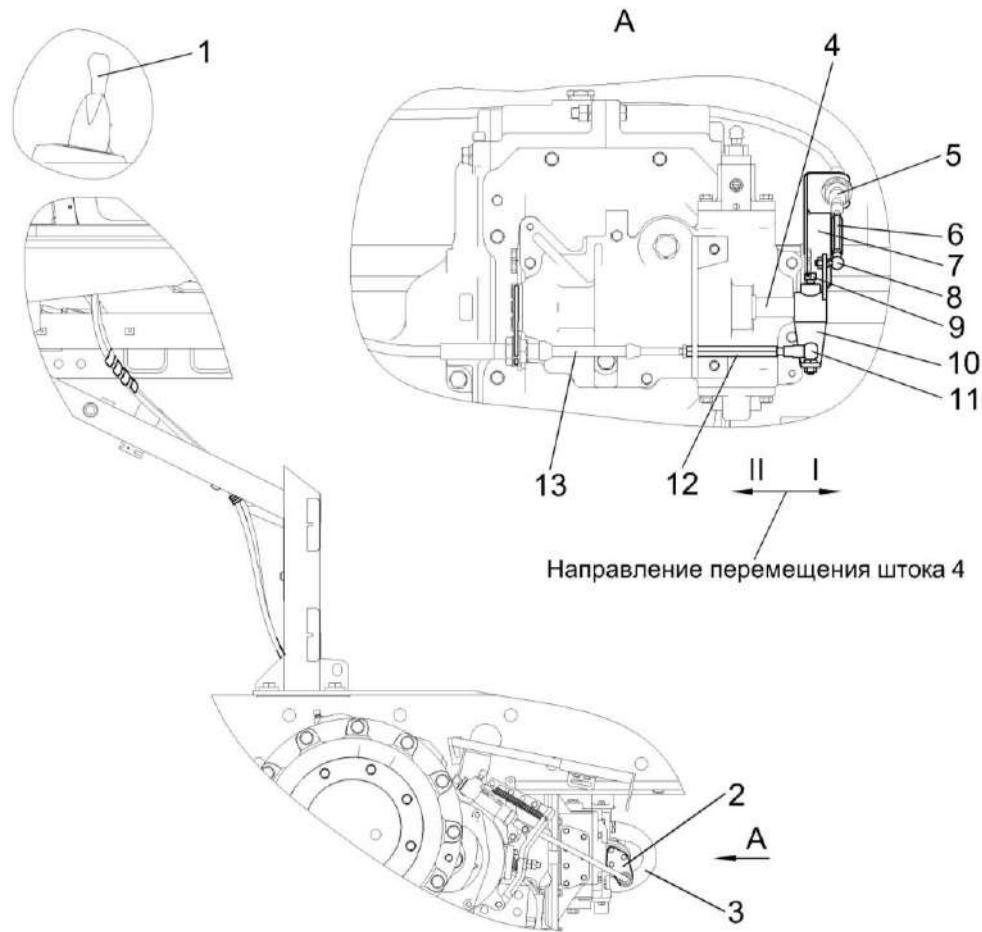
1 – рукоятка переключения передач; 2, 7 – кронштейн; 3 – скоба; 4 – шток; 5, 13 – тросы; 6, 12 – тяги; 8, 11 – шарниры угловые; 9 – болт; 10 – поводок
