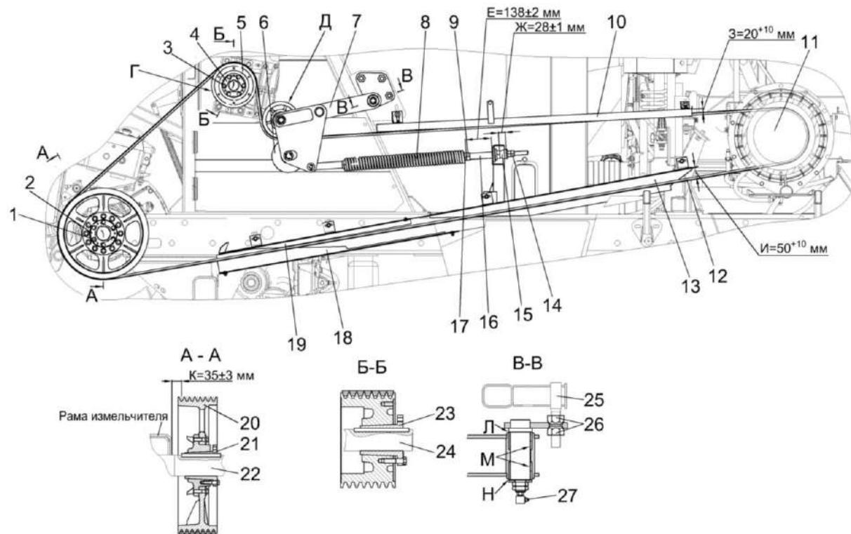
1,3 – болты; 2, 4 – пластины; 5, 11, 20 – шкивы; 6 – ролик; 7 – рычаг; 8 – пружина; 9, 14, 26 – гайки; 10, 13, 18, 19 – щитки; 12 – ремень; 15 – буфер; 16 – винт; 17 – пробка; 21, 23 – ступицы; 22 – вал измельчающего аппарата; 24 – вал ускорителя выброса; 25 – шпилька; 27 – масленка
