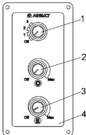
1 – ручка управления вентилятором; 2 – ручка управления термостатом кондиционера;
