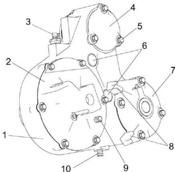
1 – корпус; 2, 4, 7 – крышки; 3 – сапун; 5 – болт; 6 – оси; 8 – ограничители угла поворота рычага верхних вальцев; 9 – пробка контрольная; 10 – пробка сливная
