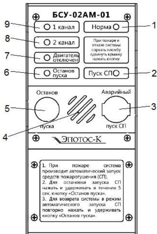
1 – индикатор «Норма»; 2 – индикатор запуска системы пожаротушения; 3 – защитная крышка кнопки «Аварийный пуск»; 4 – звуковой оповещатель; 5 – кнопка «Останов пуска»; 6 – индикатор «Останов пуска»; 7 – индикатор «Двигатель отключен»; 8, 9 – индикаторы состояния каналов
