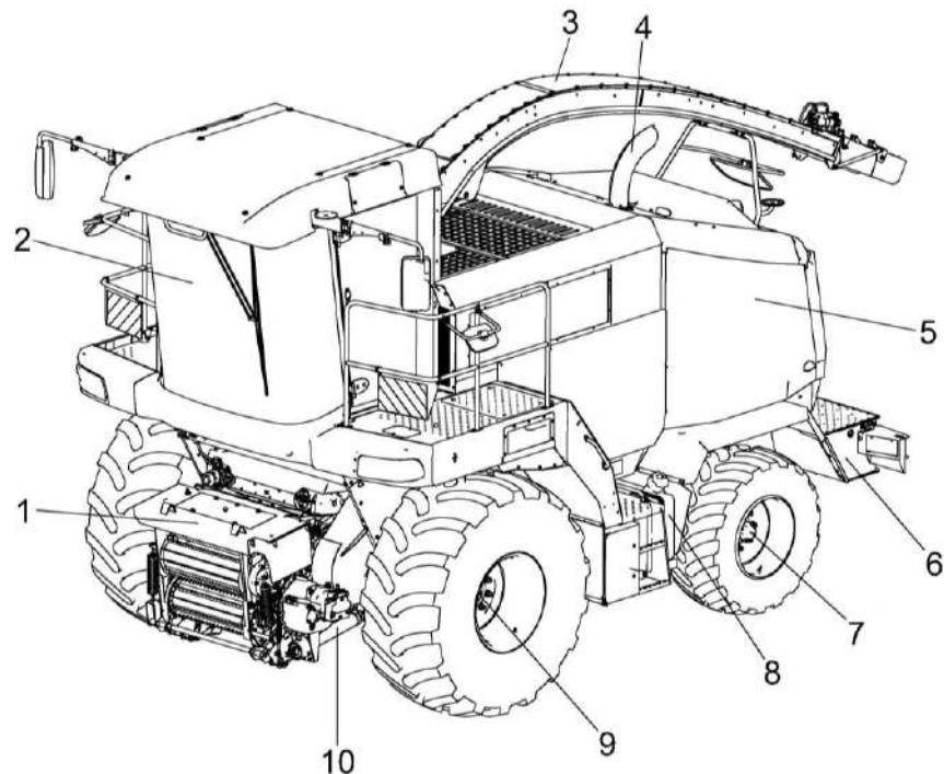
1 – аппарат питающе-измельчающий; 2 – кабина; 3 – силосопровод; 4 – установка двигателя; 5 – кабина; 6 – место установки АКБ; 7 – мост управляемых колес; 8 – бак топливный; 9 – мост ведущих колес; 10 – механизм вывешивания
