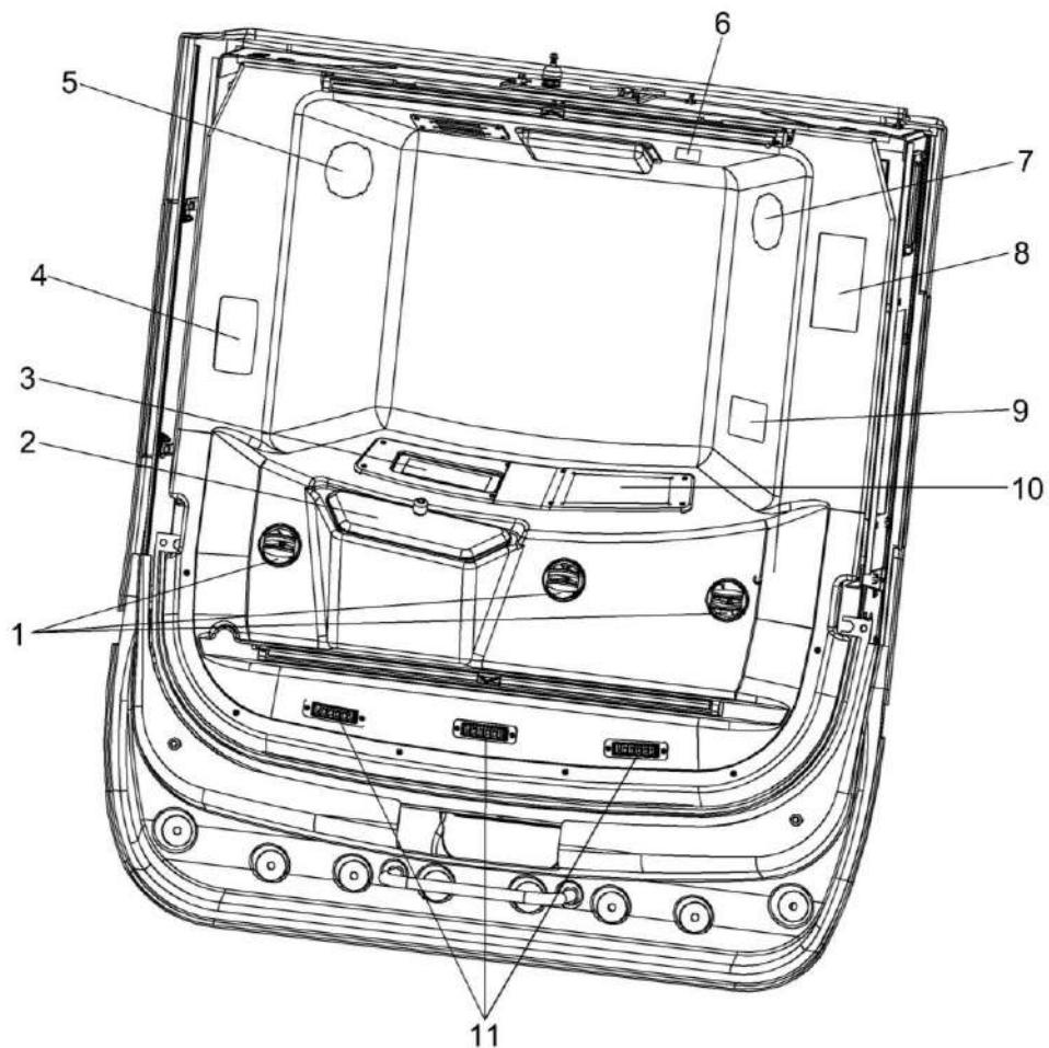
1, 11 – дефлекторы; 2 – крышка охлаждаемого бокса; 3 – автомагнитола; 4 – плафон освещения кабины; 5, 7 – динамик автомагнитолы; 6 – схема блока предохранителей; 8 – решетка фильтра рециркуляции воздуха; 9 – панель управления климатической установкой; 10 – пульт управления освещением
