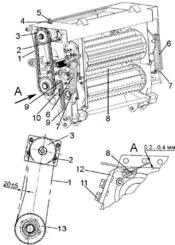
1 – цепь; 2, 4 – гайки; 3,13 – звездочки; 5, 7, 9 – контргайки; 6, 10 – пружины; 8 – валец гладкий; 11 – болт; 12 – чистик
