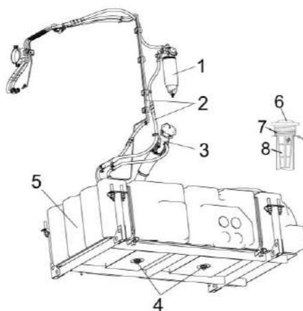
1 – фильтр; 2 – топливопроводы; 3 - заливная горловина; 4 – клапан сливной; 5 – бак; 6 – крышка; 7 – пружина; 8 - сетка
