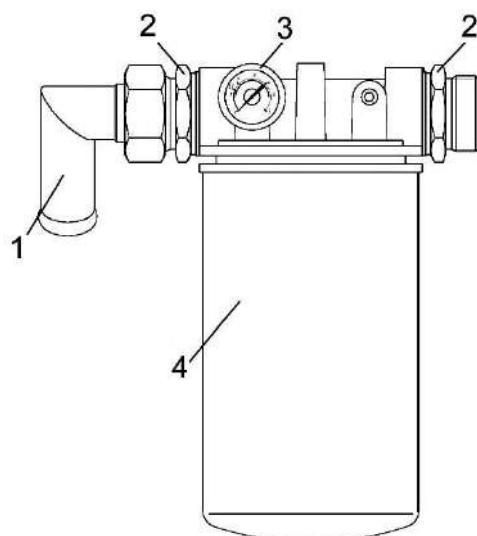
1 - угольник; 2 - штуцеры; 3 - манометр; 4 – фильтр
