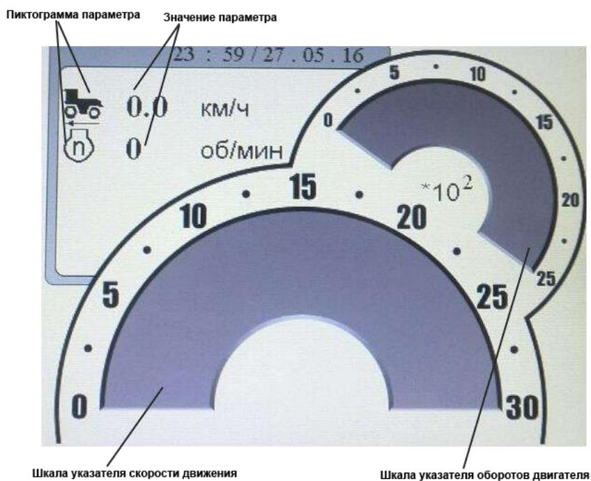
Рисунок Н.5 – Индикатор приборной панели
