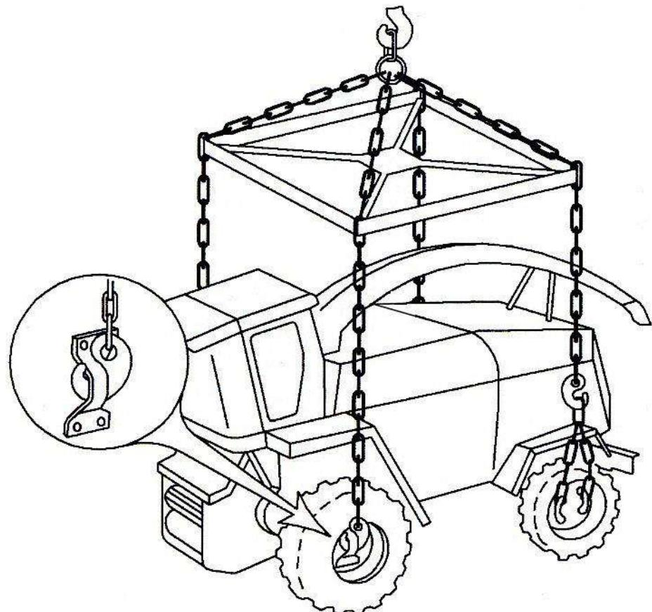
Рисунок 6.1 – Схема строповки
