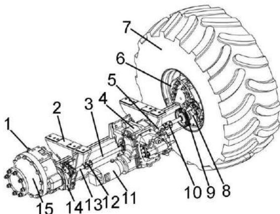
1 – сапун; 2 – балка моста; 3, 5, 13 – полуоси; 4 – коробка диапазонов; 6, 15 – бортовые редукторы; 7 – колесо; 8, 14 – муфты; 9 – датчик скорости комбайна; 10, 12 – муфты соединительные; 11 – гидромотор
