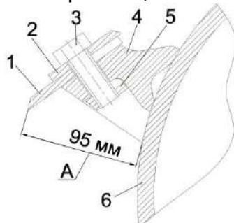
1 – нож; 2 – прижим ножа; 3 – болт; 4 – опора ножа; 5 – планка резьбовая; 6 – барабан
