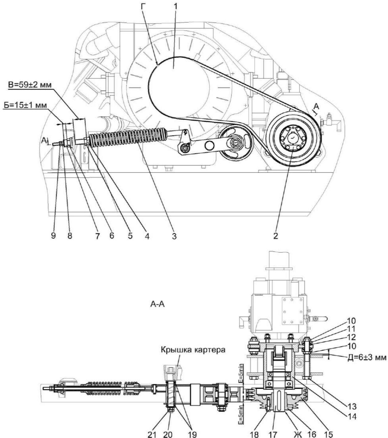
1, 15 – шкивы; 2 – пластины; 3 – пружина; 4 – пробка; 5, 8, 10, 20, 21 – гайки; 6 – винт; 7 – амортизатор; 9 – контргайка; 11 – прижимы; 12 – шайба сферическая; 13, 18 – болты; 14 – опора; 16 – ступица; 17 – вал; 19 – шайбы
