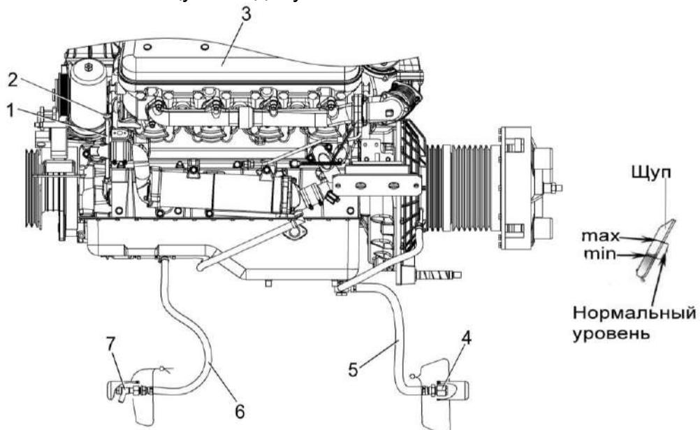
1 – горловина заливная; 2 – крышка; 3 – двигатель; 4 – пробка; 5 – рукав слива масла; 6 – рукав слива охлаждающей жидкости; 7 – кран
