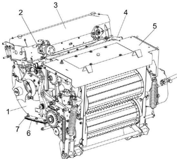
1 – аппарат измельчающий; 2, 4 - скоба; 3 – заточное устройство; 5 – аппарат питающий;
