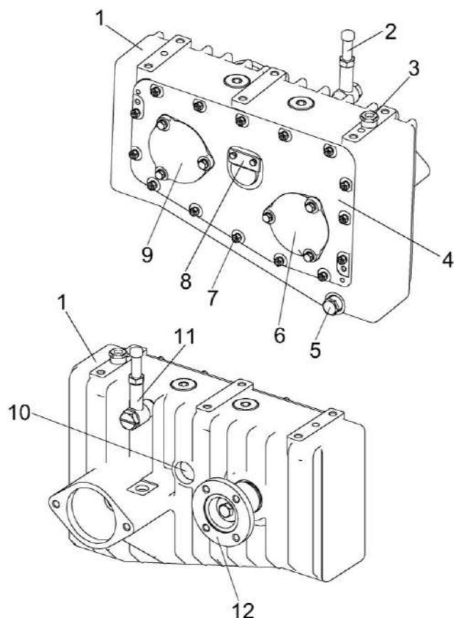
1 - корпус; 2 - сапун; 3 - маслоуказатель; 4, 6, 9 – крышки; 5 - пробка; 7 - болт; 8 – упор; 10 - ось; 11 – угольник; 12 - фланец
