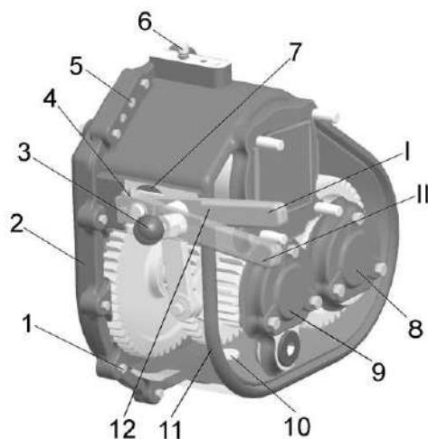
1 – болт; 2, 11 – корпуса; 3 – ручка шаровая; 4 - клеммовое соединение; 5 - штифт;
