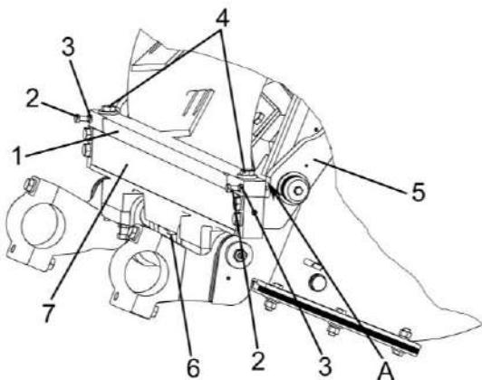
1 – брус противорежущий; 2 – болты упорные; 3 – контргайки; 4 – болты верхние крайние крепления бруса; 5 – рычаг; 6 – болт нижний крепления бруса; 7 – подбрусьник
