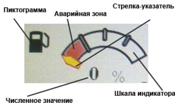
Рисунок Н.3 – Пример стрелочного индикатора
