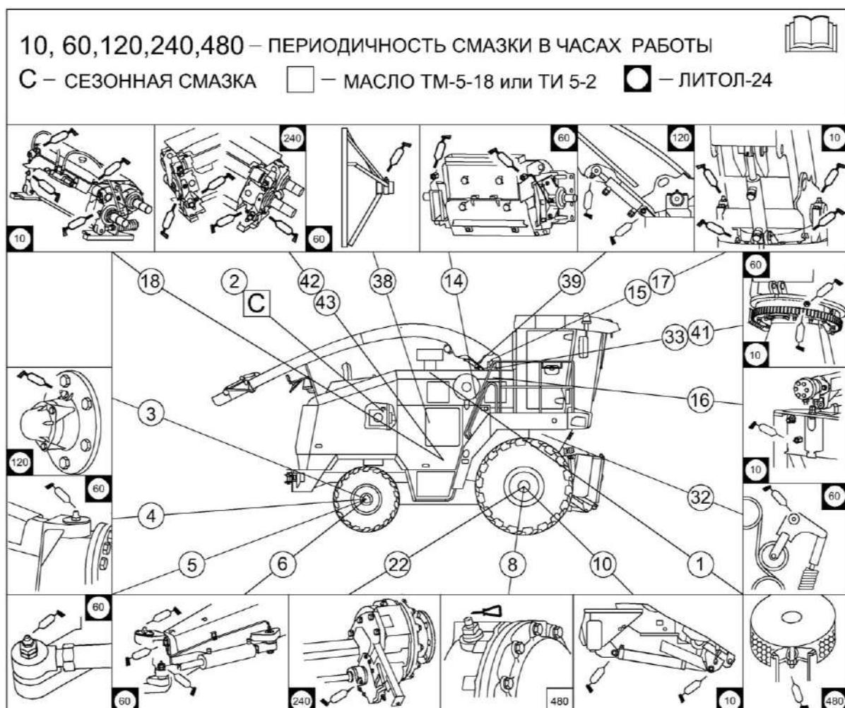
Рисунок 3.12 – Схема смазки комбайна (вид справа)
