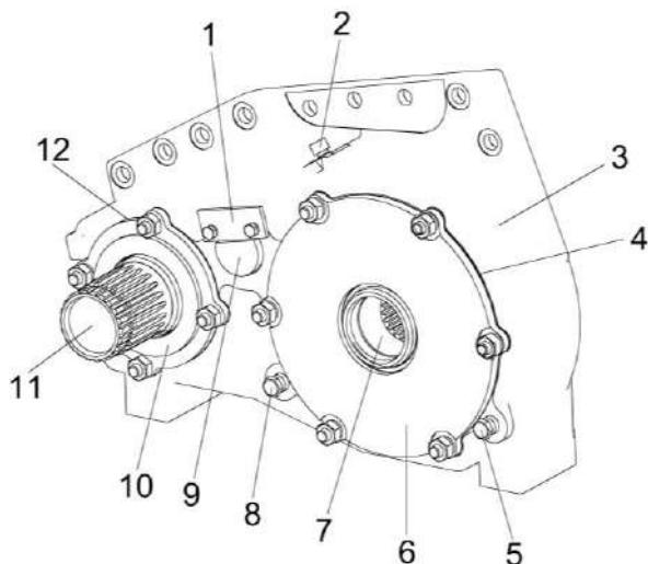
1 – упор; 2 – сапун; 3 – корпус; 4, 12 – прокладки; 5 – пробка сливная; 6, 10 – крышки;
