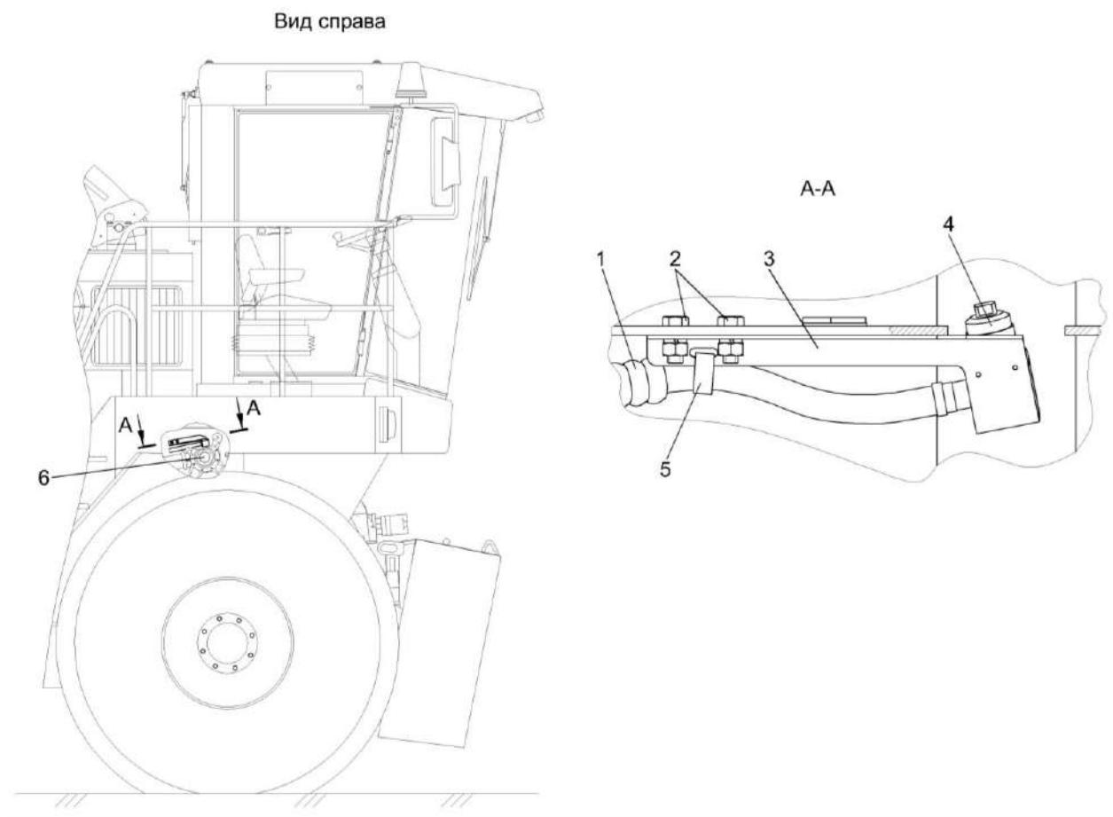
1 – рукав для подвода консервантов; 2 – болты; 3 – кронштейн; 4 – распылитель; 5 – хомут; 6 – ускоритель выброса
