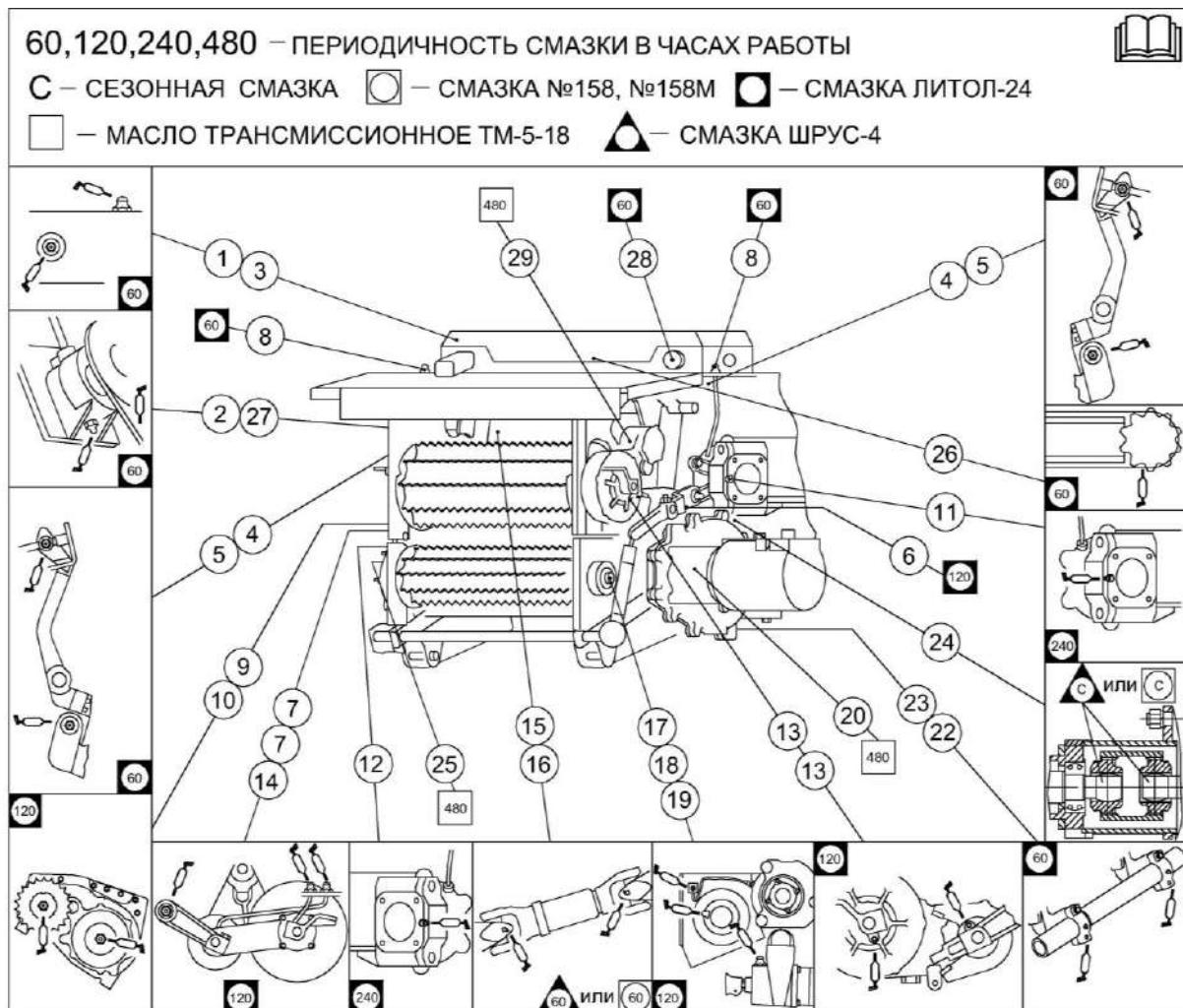
Рисунок 3.14 – Схема смазки питающе-измельчающего аппарата комбайна
