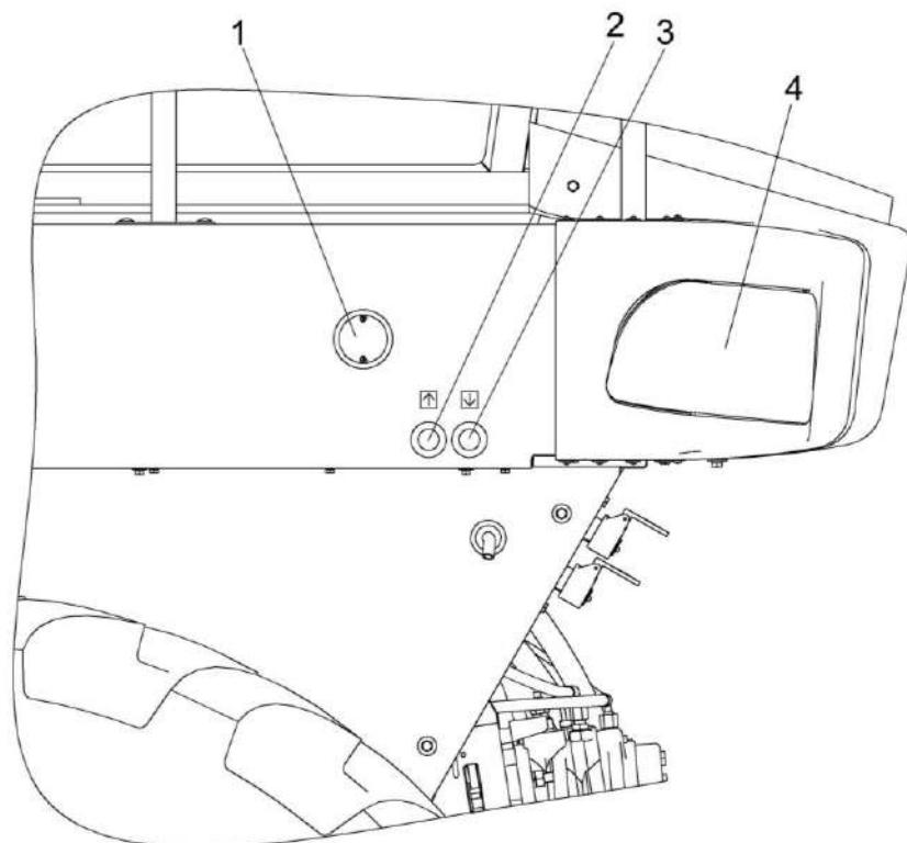
1 – боковой повторитель указателя поворотов; 2 – кнопка подъема адаптеров; 3 – кнопка опускания адаптеров; 4 – фара транспортная
