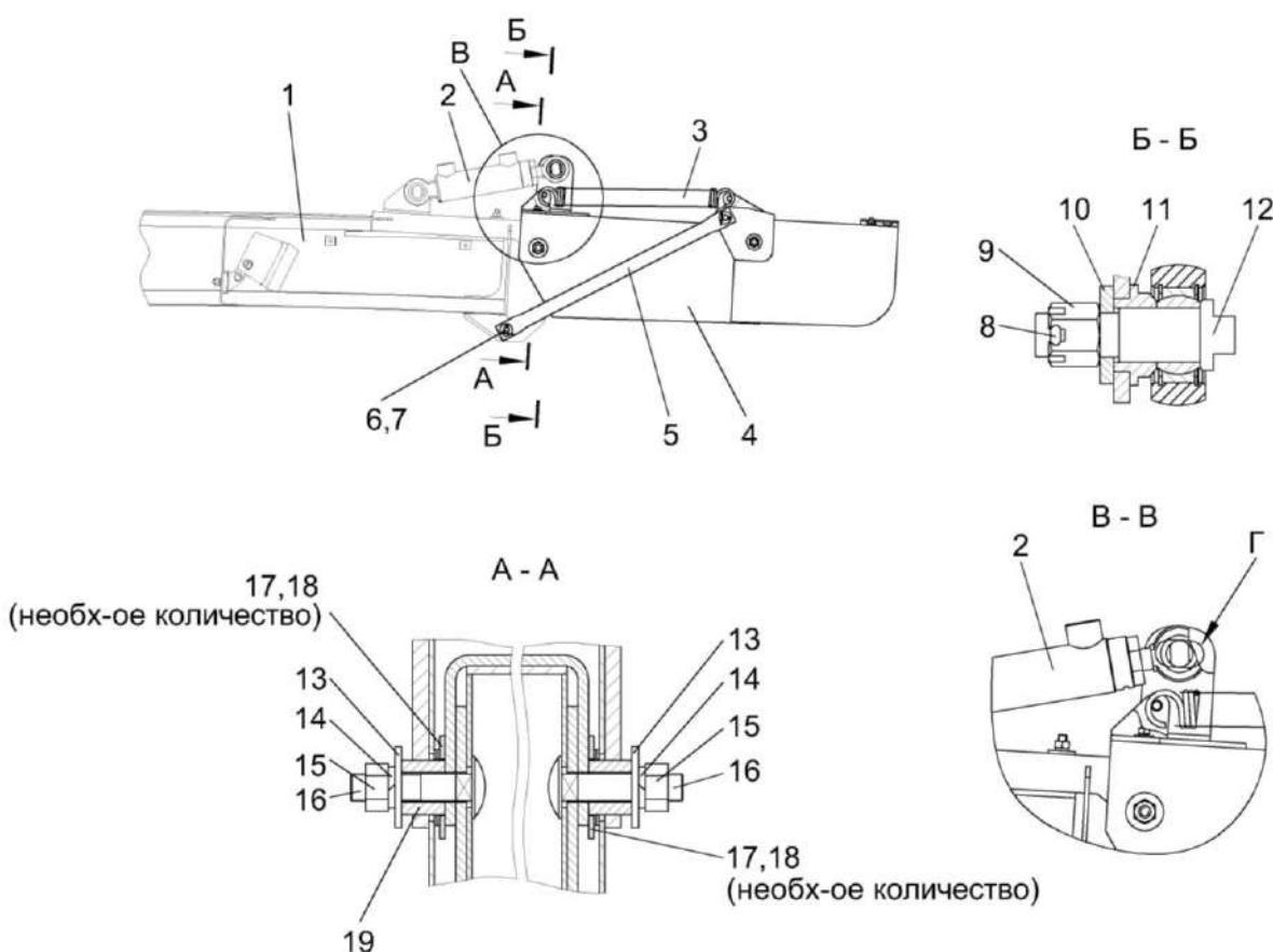
1 – силосопровод; 2 – гидроцилиндр; 3 – пружина; 4 – козырек; 5 – тяга; 6, 10, 13, 14, 17 – шайбы; 7, 8 – шплинты; 9, 15 – гайки; 11 – бонка; 12 – ось; 16 – болты; 18 – прокладки; 19 – втулки
