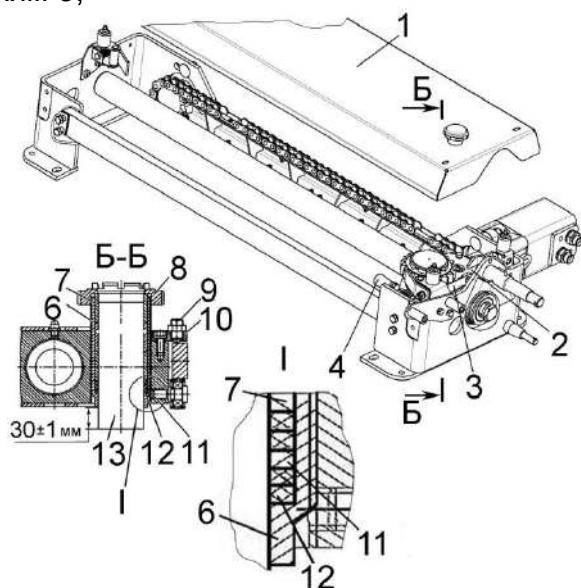
1 – крышка; 2 – каретка; 3 – прижим; 4 – фиксатор; 6 – втулка резьбовая; 7 – втулка; 8 – колесо храповое; 9 – устройство стопорное; 10 – планка; 11 – кольцо; 12 – кольца резиновые (4 шт); 13 – брускок абразивный
