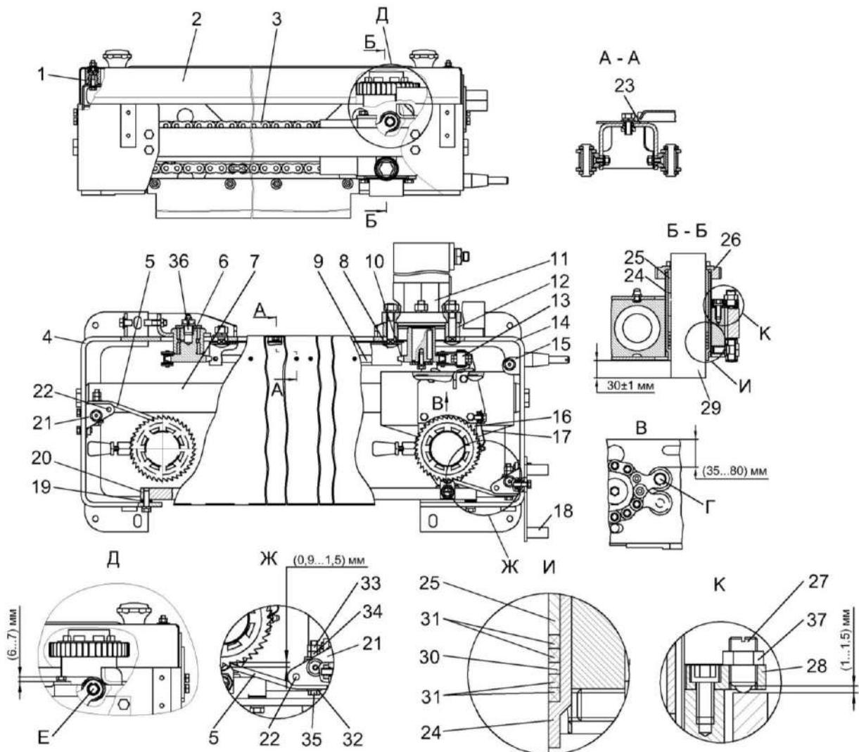
1 – обойма; 2 – крышка; 3, 13 – цепь; 4, 8, 14, 15, 18 – кронштейны; 5 – упор; 6, 10 – звездочки; 7, 9, 20 – направляющие; 11 – гидромотор заточного устройства; 12 – фланец; 16 – каретка; 17 – прижим; 19 – пластина стопорная; 21 – опора; 22 – ось; 23 – ограждение; 24 – втулка резьбовая; 25 – втулки; 26 – колесо храповое; 27 – устройство стопорное; 28 – планка; 29 – бруск абразивный; 30 – кольцо; 31 – кольца резиновые; 32 – шайба; 33, 37 – контргайки; 34 – гайка; 35 – болт; 36 – штуцер
