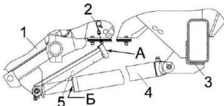
1 – питающе-измельчающий аппарат; 2 – пружина; 3 - балка моста; 4 – гидроцилиндр; 5 – упор
