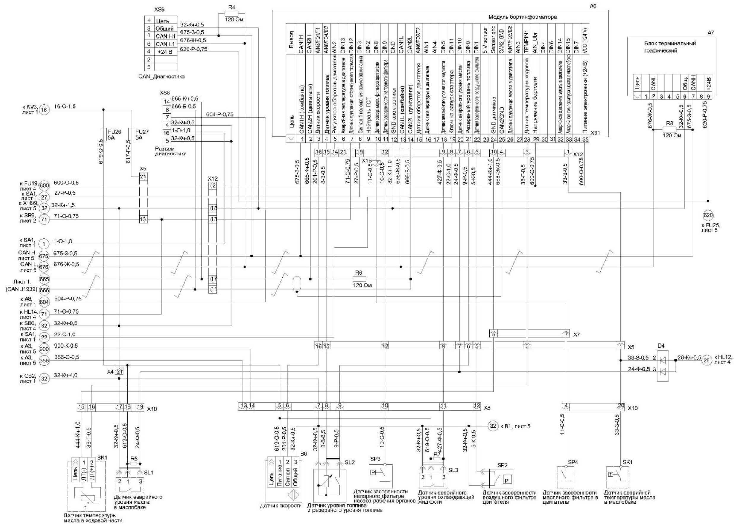
Рисунок Б.1 - Схема электрическая принципиальная комбайна (лист 6)
