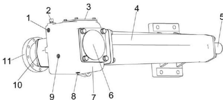
1 – пробка заливная; 2 – сапун; 3, 6, 10 – крышки; 4 – стакан; 5 – ступица приводного шкива; 7 – корпус; 8 – пробка сливная; 9 – пробка контрольная; 11 – ступица установки вентилятора
