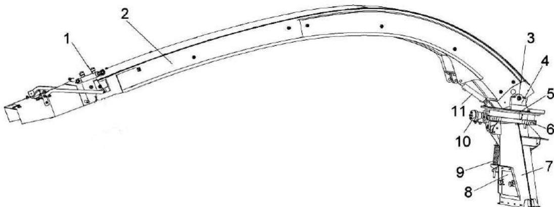
1, 11 – гидроцилиндры; 2 – силосопровод; 3 – ось; 4 – опора; 5 - фланец; 6 - колесо; 7 – основание силосопровода; 8 – люк; 9 – пружина; 10 – механизм поворота
