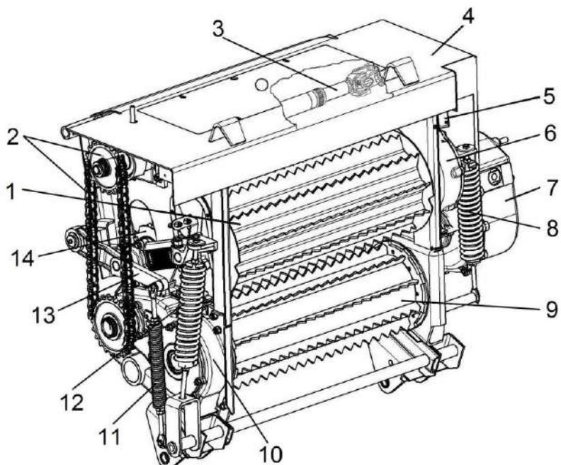
1 – валец верхний передний; 2 – передача цепная; 3 – вал карданный; 4 – корпус; 5 – датчик камнедетектора; 6 – редуктор верхних вальцев; 7 – коробка передач; 8, 11, 12 – пружины; 9 – вальцы нижние; 10 – редуктор нижних вальцев; 14 - валец верхний задний
