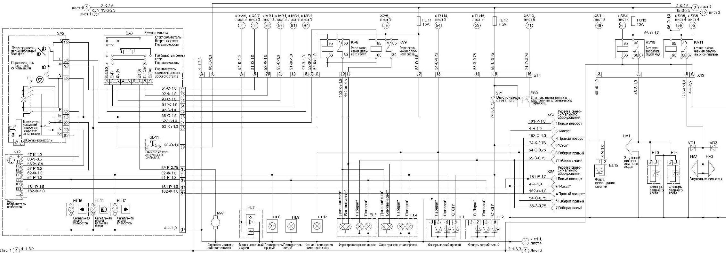
Рисунок Б.1 – Схема электрическая принципиальная комбайна (лист 2)
