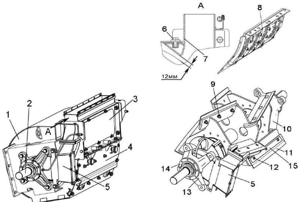
1 – корпус ускорителя; 2 – вал ускорителя выброса; 3 – стенка задняя; 4 – поддон; 5 – воздуховод; 6, 12 – болты; 7 – отсекатель; 8 – поддон бичевой; 9 – гайка; 10, 13 - корпуса; 11 – лопасть; 14 – крышка; 15 – накладка
