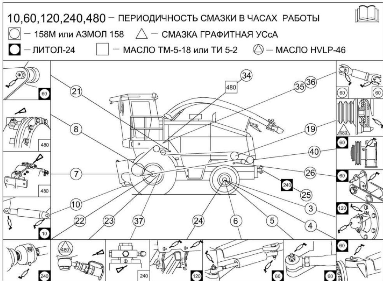
Рисунок 3.13 – Схема смазки комбайна (вид слева)
