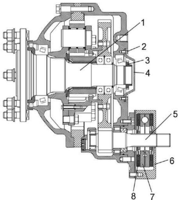
1 – ось колеса; 2 – болты; 3 – шайба; 4 – крышка; 5 – вал ведущий; 6 – корпус тормоза; 7 – диск нажимной; 8 – диск фрикционный
