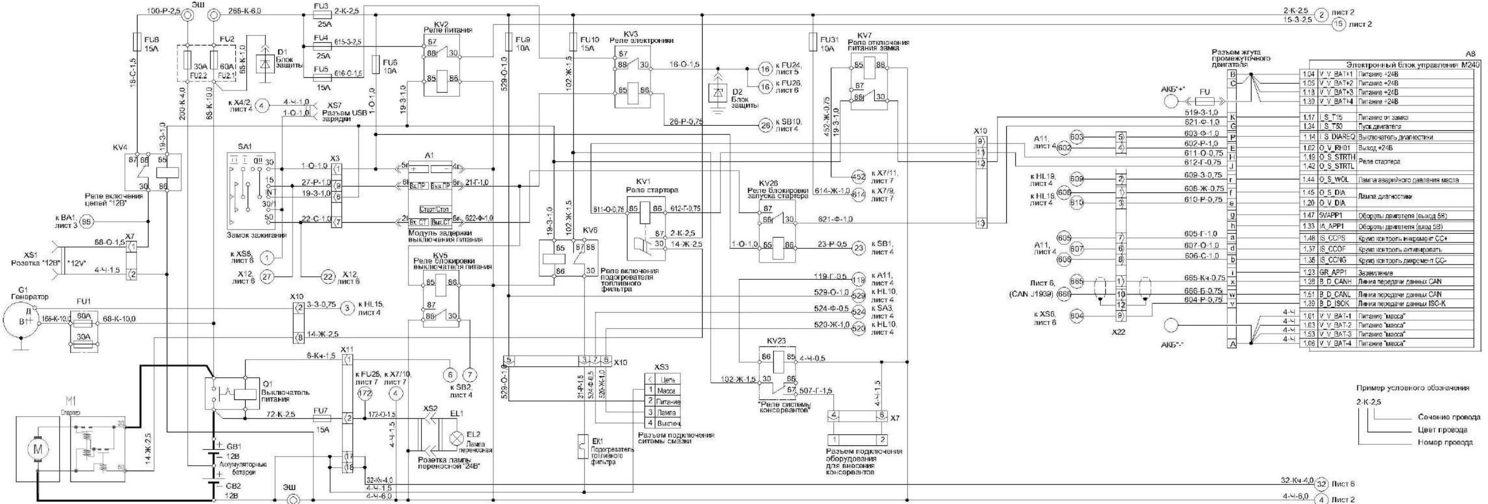
Рисунок Б.1 – Схема электрическая принципиальная комбайна (лист 1)
