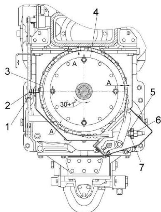
1, 7 – контргайки; 2, 5 – винты; 3 - лента тормозная; 4 – барабан тормозной; 6 - гайка регулировочная
