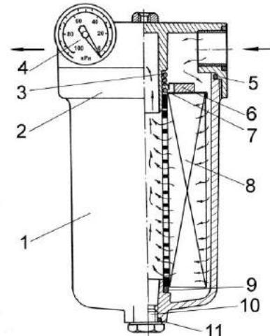
1 – стакан; 2 – корпус; 3 – пружина;
