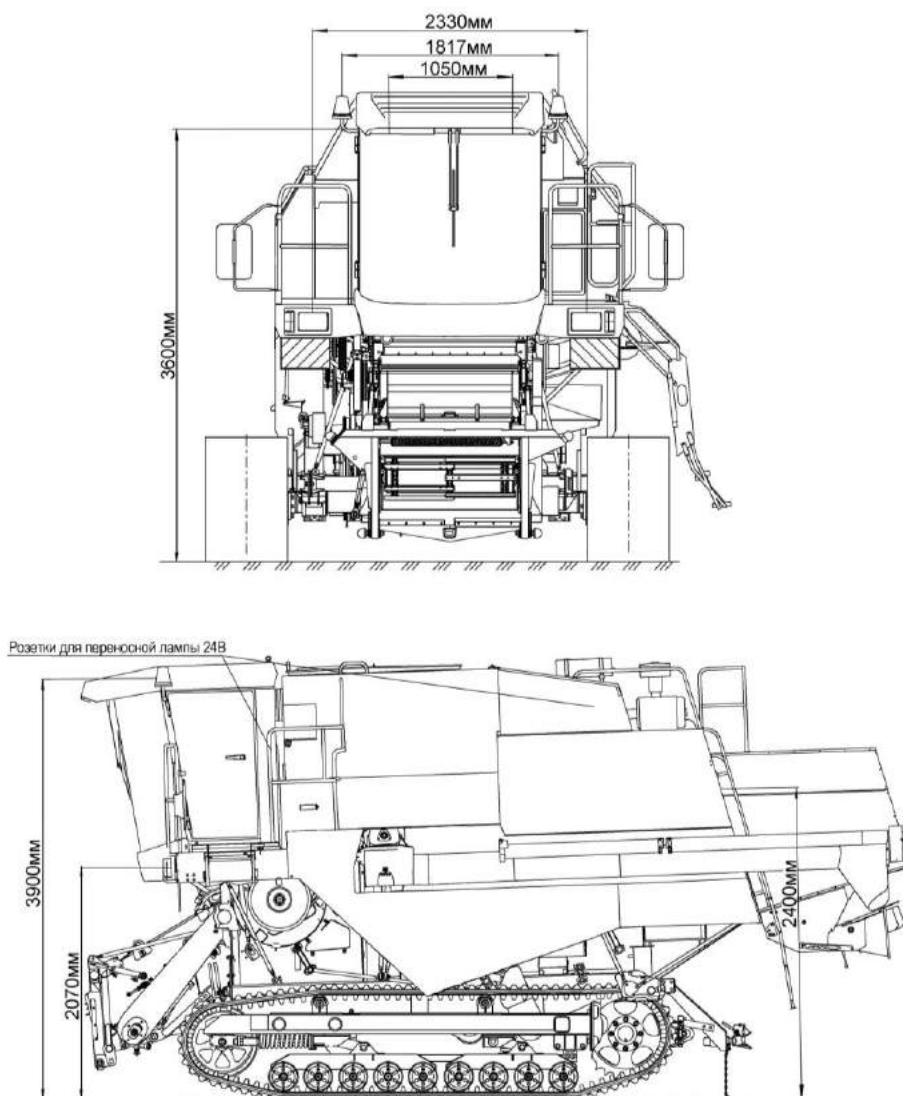
Рисунок 1.27 – Расположение наружного освещения и световой сигнализации комбайна
