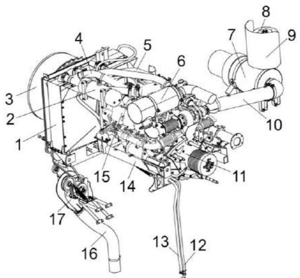
1 – блок радиаторов; 2 – бачок расширительный; 3 – воздухозаборник; 4, 10, 16 - трубы воздушные; 5 – труба водяная; 6 - глушитель; 7 – воздухоочиститель; 8 – воздухозаборник врачающийся; 9 – экран; 11 – главный привод; 12 – сливной рукав охлаждающей жидкости; 13 – сливной рукав масла; 14 - рама подмоторная; 15 - двигатель; 17 – вентилятор
