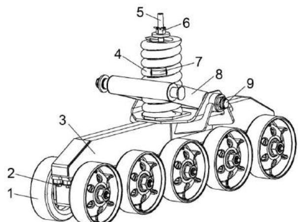
1 - каток опорный; 2 - болт; 3 - рама каретки; 4, 7 - пружины; 5 - винт; 6 - гайка прорезная; 8 - траверса каретки; 9 - ось
