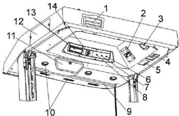
1 – крышка блока предохранителей; 2 – панель управления кондиционером; 3 – динамик автомагнитолы; 4 – фильтр рециркуляции воздуха; 5 – плафон освещения кабины; 6 – кнопка включения задних рабочих фар; 7 – кнопка включения передних рабочих фар; 8 – кнопка включения маяков; 9 – солнцезащитная шторка; 10 – дефлекторы; 11 – охлаждаемый бокс; 12 – место установки воздушного фильтра; 13 – место для магнитолы; 14 – ручка включения стеклоочистителя
