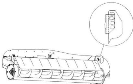
Рисунок 2.14 – Регулировка ограждения над горизонтальным шнеком бункера
