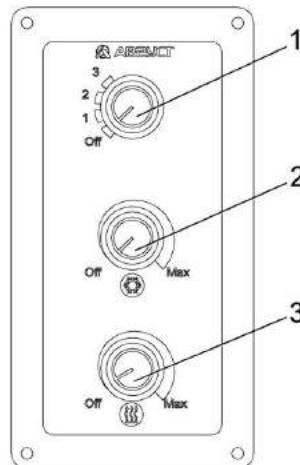
1 – ручка управления вентилятором; 2 – ручка управления термостатом кондиционера; 3 – ручка управления термостатом отопителем;
