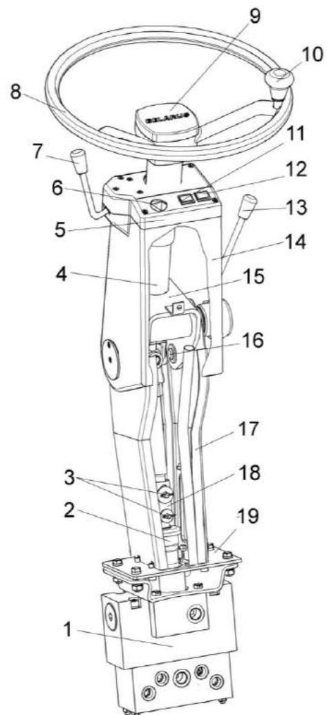
1 - насос дозатор; 2 - опора; 3, 16 – оси;
