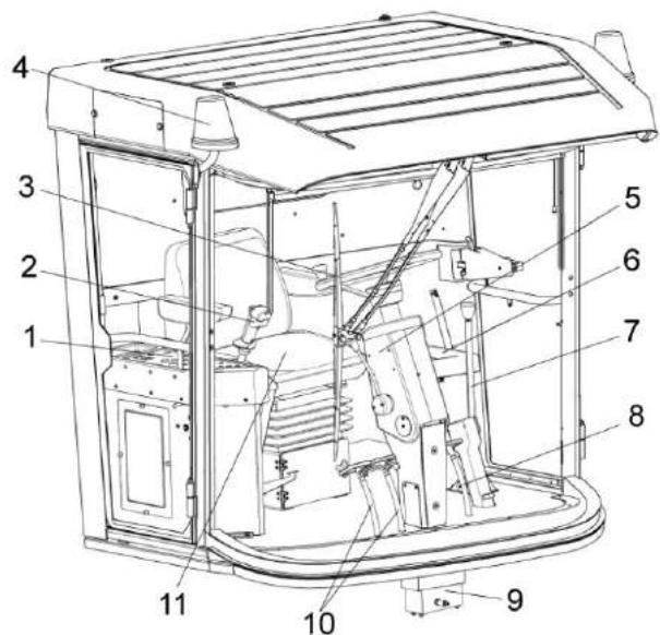
1 – пульт управления; 2 – рукоятка управления скоростью; 3 - стеклоочиститель; 4 – маяк проблесковый; 5 – колонка рулевая; 6 – дополнительное сиденье; 7 – рычаг переключения передач; 8 – педаль блокировки коробки диапазонов; 9 – блок рулевого управления; 10 – тормозные педали; 11 - сиденье
