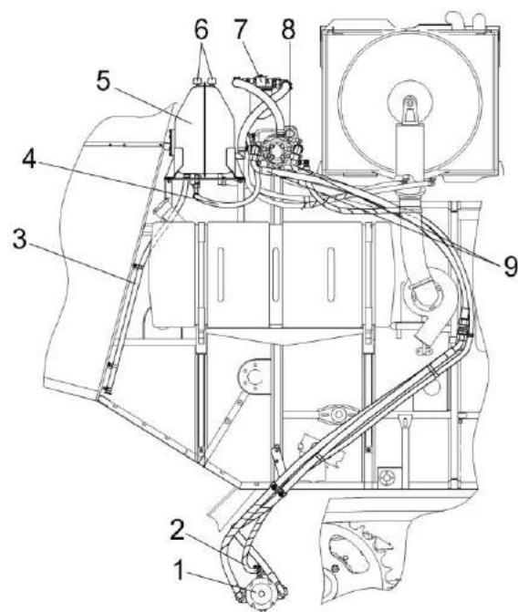
1 – гидромотор аксиально поршневой;
