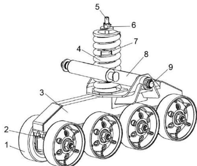
1 - каток опорный; 2 - болт; 3 - рама каретки; 4, 7 - пружины; 5 - винт; 6 - гайка прорезная; 8 - траверса каретки; 9 - ось
