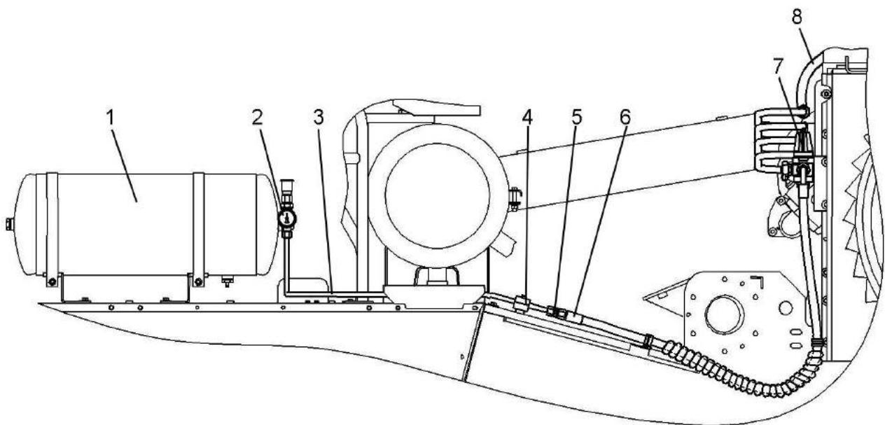
1 – ресивер; 2 – манометр; 3 – трубопровод; 4 – клапан обратный; 5 – штуцер; 6, 8 – рука-ва высокого давления; 7 – регулятор давления
