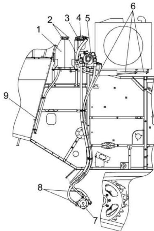
1 – бак масляный; 2 – сапуны; 3 – вакуумметр; 4 – фильтр; 5 - насос аксиально – поршневой; 6 – рукава низкого давления; 7 – гидромотор аксиально поршневой; 8 - рукава высокого давления; 9 – сливной рукав
