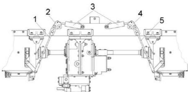
1, 5 - тяги; 2, 4 - рычаги; 3 - гидроцилиндры
