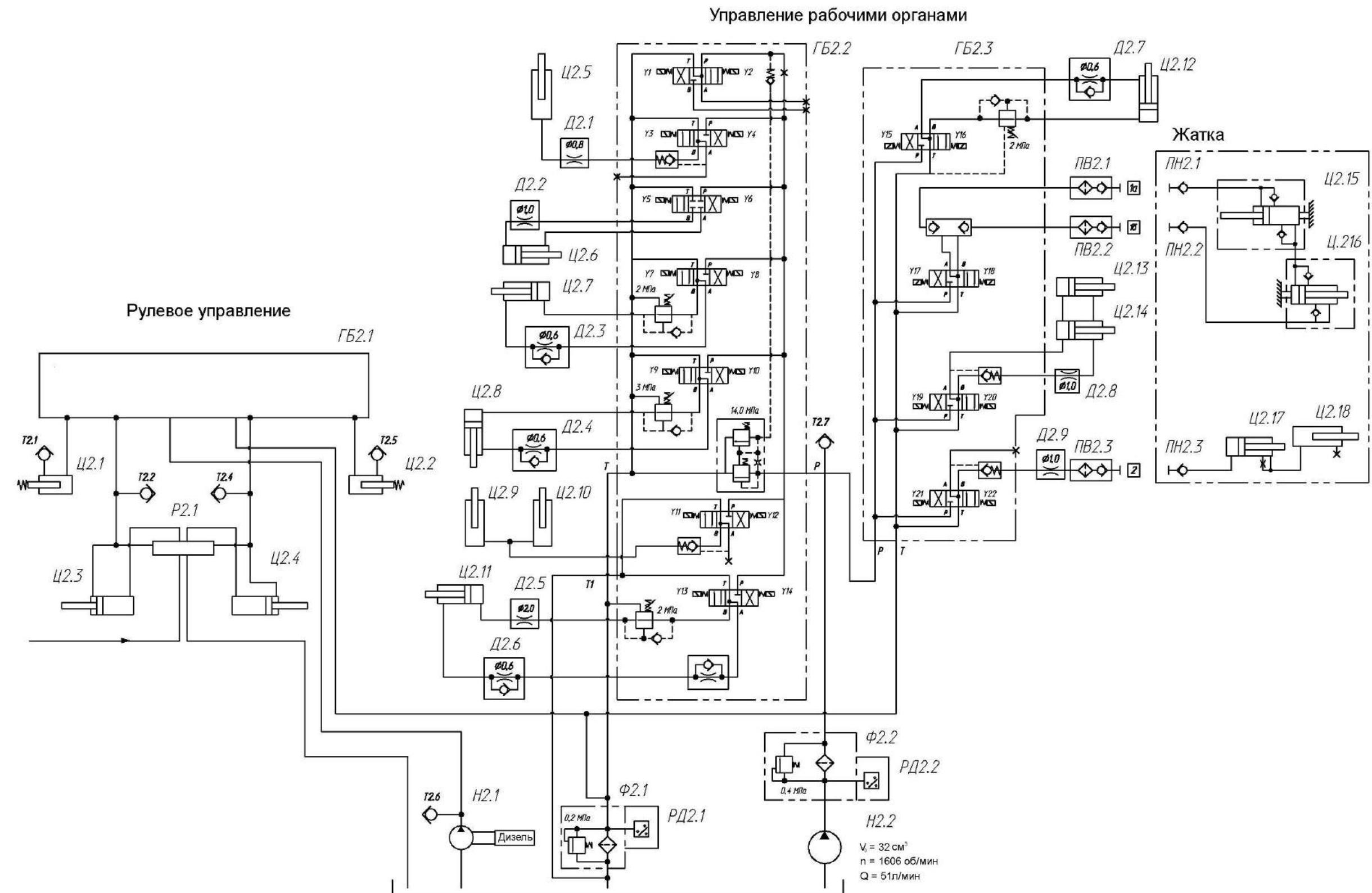
Рисунок А1 – Схема гидросистемы рулевого управления и силовых гидроцилиндрков
