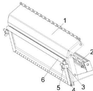
1 – основание; 2 – щит; 3 – прижим; 4 -ось; 5 – гайка-барашек; 6 – крышка
