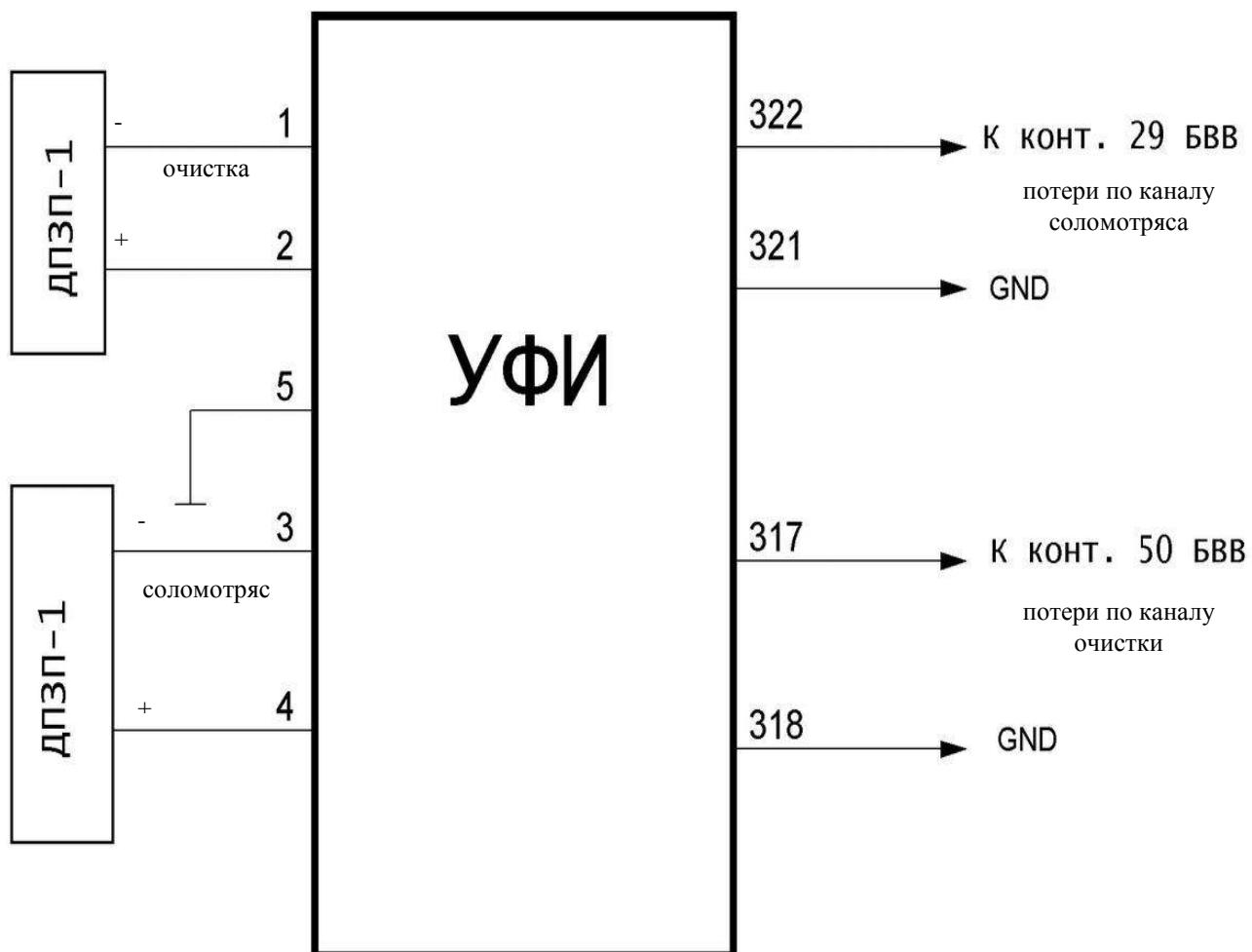
ДПЗП-1 – датчик потерь зерна пьезоэлектрический
