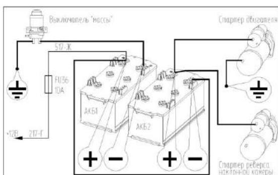
Рисунок 2.2 - Подключение аккумуляторных батарей
