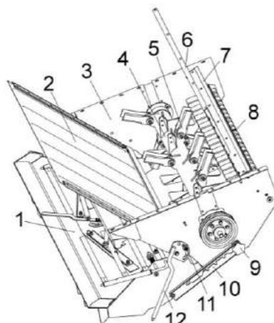
1 – дефлектор; 2 – заслонка; 3 – корпус измельчителя; 4 - ротор измельчителя; 5 – нож; 6 – стенка; 7 – брус противореза 8 – ножевая опора; 9 – фиксатор; 10 – полоз; 11 – гайка; 12 - рукоятка сектора
