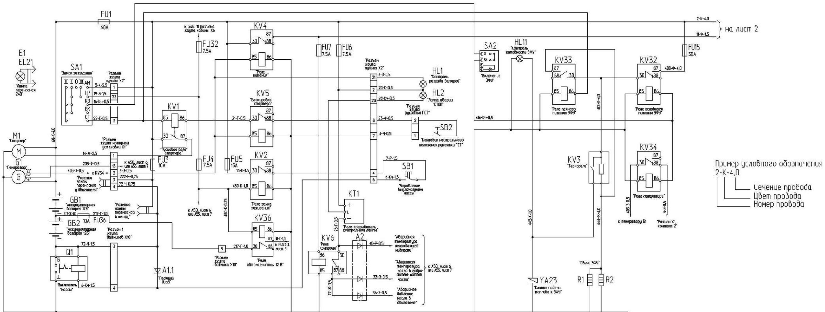
Рисунок Б.1 – Схема электрическая принципиальная комбайна (лист 1)
