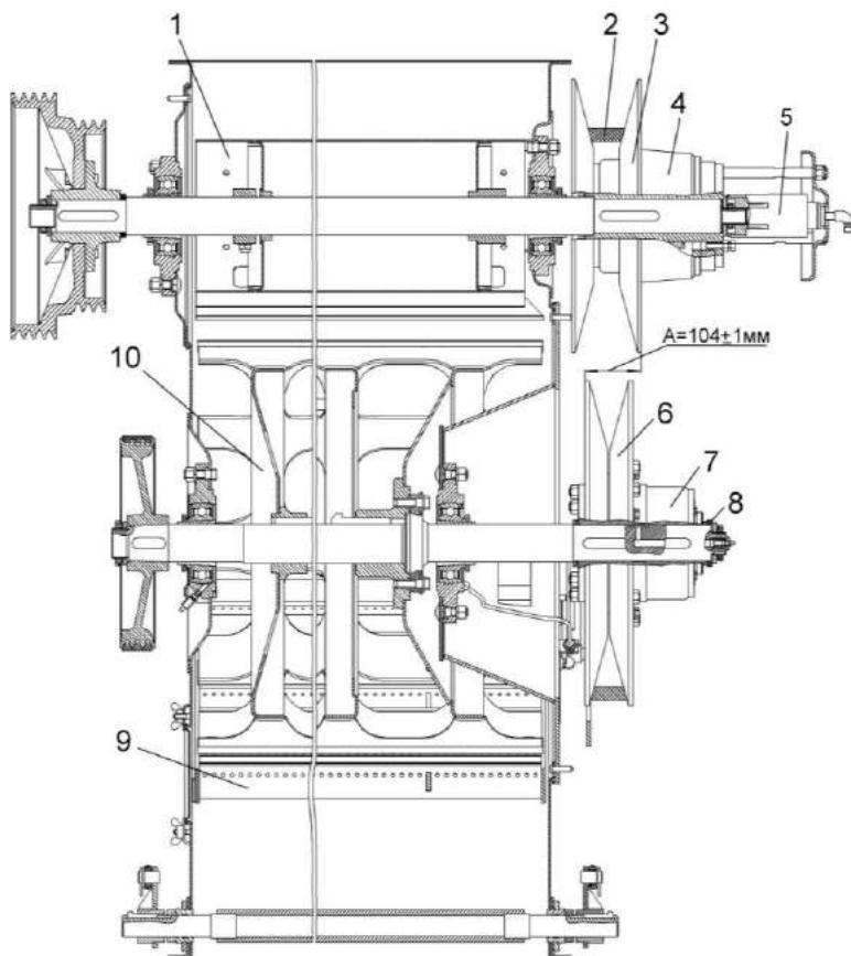
1 – битер отбойный; 2 – ремень; 3 – ведущий шкив; 4, 7 – вариаторы барабана; 5 - гидроцилиндр; 6 – ведущий шкив; 8 - прокладки регулировочные; 9 – подбарабанье; 10 - барабан молотильный
