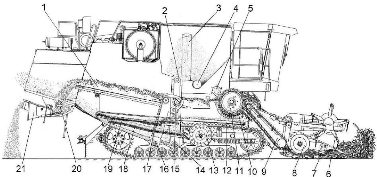
1 - соломотряс; 2 - элеватор зерновой; 3 - шнек загрузной зерновой; 4 - шнек горизонтальный; 5 - битер отбойный; 6 - мотовило; 7 - режущий аппарат; 8 - шнек; 9 - транспортер наклонной камеры; 10 - подбарабанье; 11 - молотильный барабан; 12 - стрясная доска; 13 - вентилятор; 14 - шнек зерновой; 15 - устройство домолачивающее; 16 - шнек колосовой; 17 - элеватор колосовой; 18 - стан решетный нижний; 19 - стан решетный верхний; 20 - соломоизмельчитель; 21 – дефлектор
