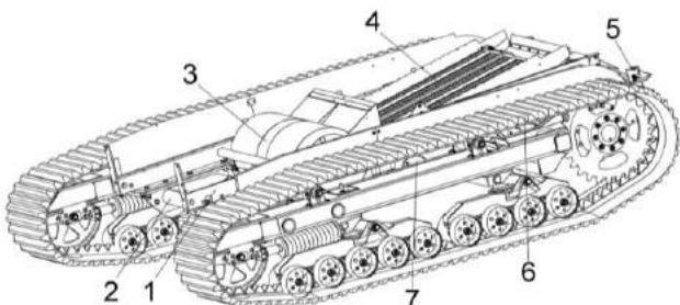
1 – рама шасси; 2 – балка; 3 – вентилятор очистки; 4 - стан решетный нижний; 5 – устройство тяговое; 6 - тележка гусеничная; 7 – блок шнеков
