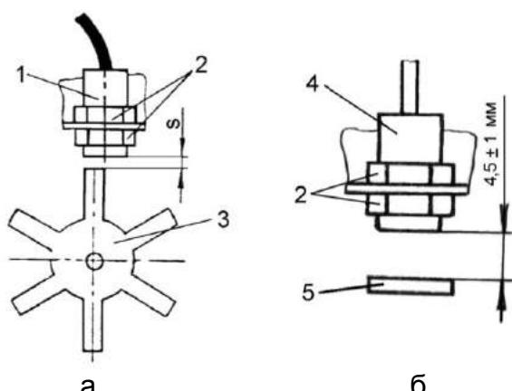
1 – датчик; 2 – регулировочные гайки;
