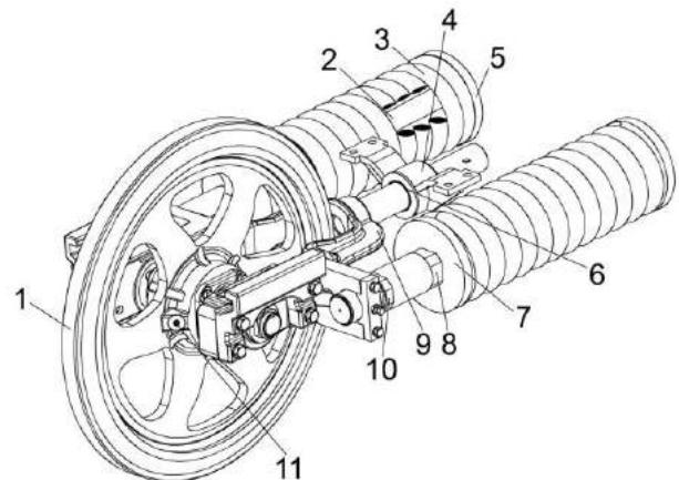
1 - колесо направляющее; 2 - болт пружины; 3 - пружина; 4 - кронштейн; 5 - упор пружины; 6 - втулка; 7 - шайба направляющая; 8 - гайка; 9 - вилка; 10 - гайка регулировки натяжения; 11 - масленка
