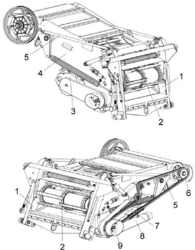
1 – рамка переходная; 2 – цепочно-планчатель транспортер; 3 – реверс; 4 - рама; 5 – механизм продольного копирования; 6 - вал верхний; 7 - цепочка; 8 – упор; 9 – вал нижний
