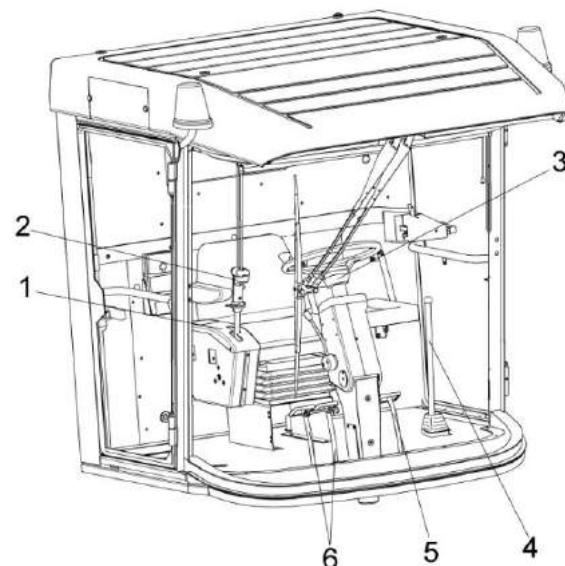
1 – пульт управления; 2 – рукоятка управления скоростью движения; 3 - рулевая колонка; 4 - рычаг переключения передач; 5 – педаль блокировки коробки диапазонов; 6 – тормозные педали;
