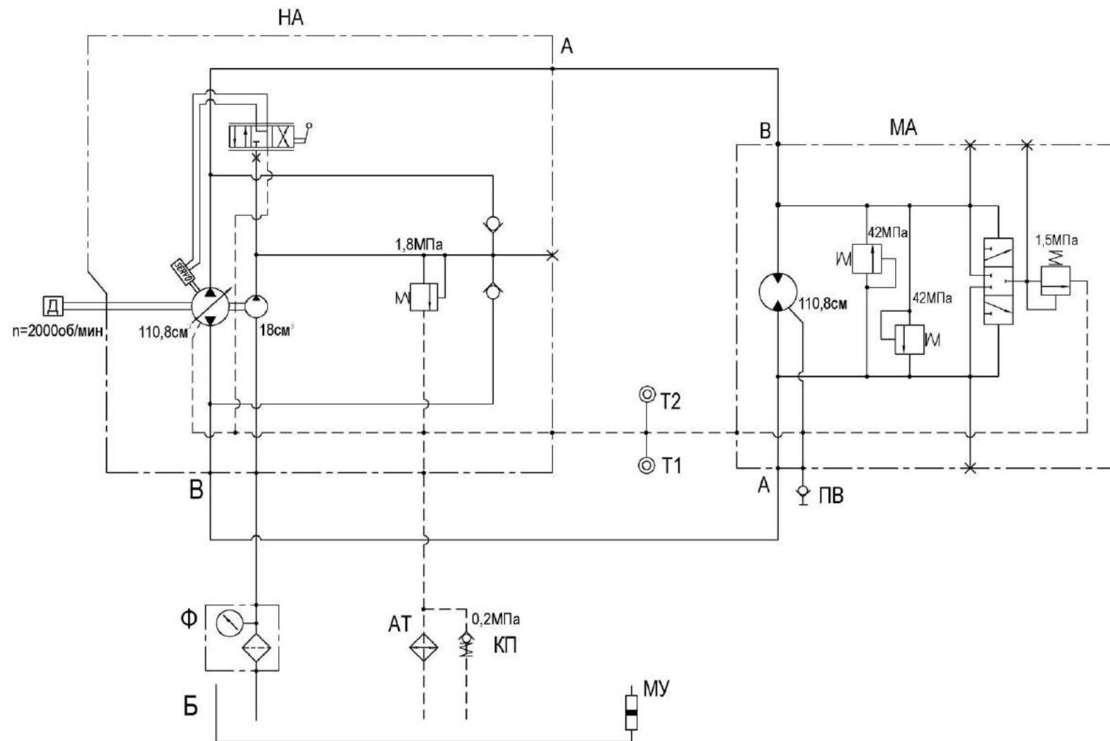
АТ – масляная секция радиатора; Б – бак масляный; КП – клапан обратный; МА – гидромотор аксиально – поршневой; НА – гидронасос аксиально - поршневой; ПВ – полумуфта внутренняя; Т1 – датчик ДУТЖ - 01; Т2 - датчик сигнализатора температуры; МУ – указатель уровня масла; Ф - фильтр
