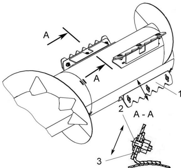
1 – лопатка; 2 – болт; 3 – гайка
