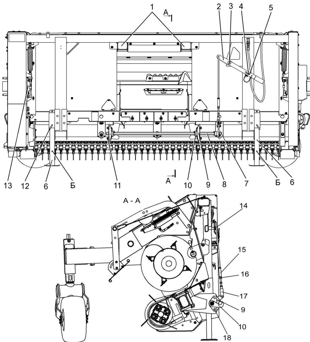
1 – кронштейны; 2 – рукоятка; 3 – ось рукоятки; 4 – фиксатор; 5 – шплинт; 6 – опора стояночная; 7 – рычаг; 8 – вал; 9 – ловитель; 10 – крюк; 11 – гайка; 12 – фиксатор опоры; 13 – контрпривод; 14 – тяга; 15 – стяжка; 16 – гайка; 17 – вилка; 18 – болт
