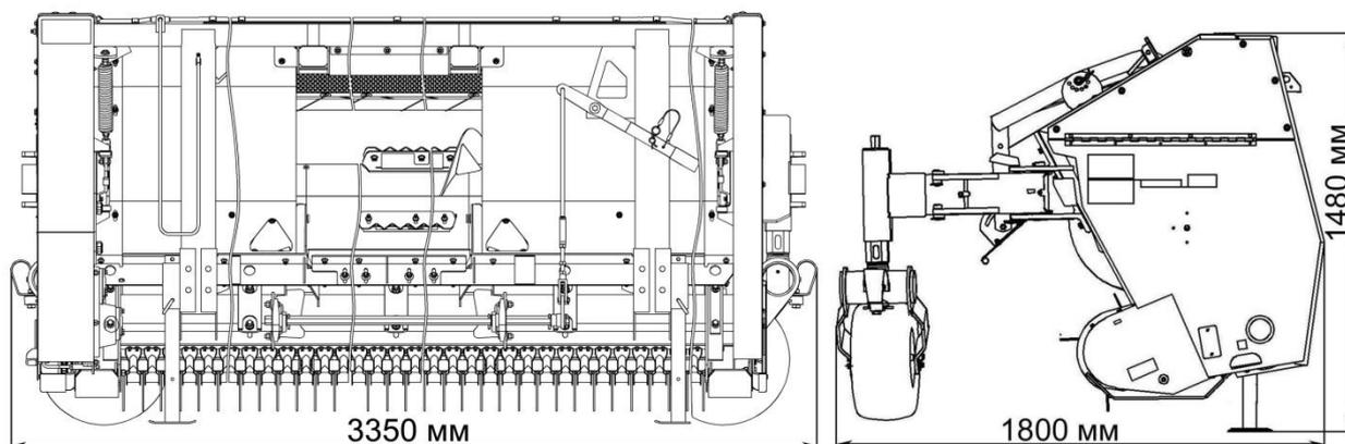
Рисунок 1.2 – Габаритные размеры подборщика
