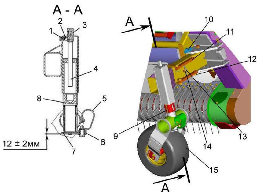
1 – пружина; 2 – шарик; 3 – наконечник; 4 – винт регулировочный; 5 – пружина; 6 – ролик; 7 – копир; 8 – ось колеса; 9 – линейки; 10 – фиксатор; 11 – упор; 12 – шплинт быстро-съемный; 13 – планка; 14 – болт; 15 – колесо флюгерное
