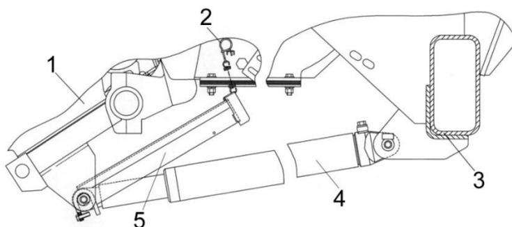
1 – питающе-измельчающий аппарат; 2 – пружина; 3 – балка моста; 4 – гидроцилиндр;
