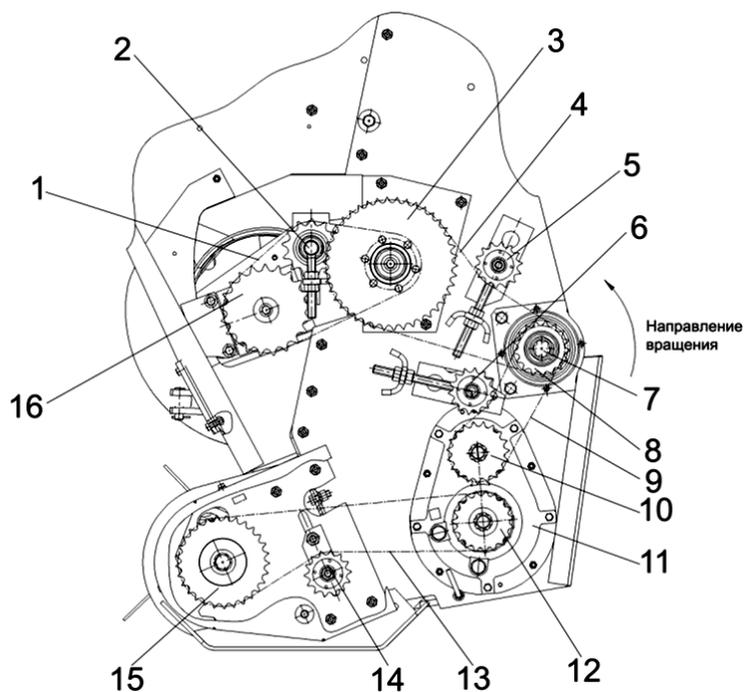
1 – цепная передача привода шнека; 2, 5, 6, 14 – натяжные устройства; 3, 8, 10, 12, 15, 16 – звездочки приводов; 4, 9 – промежуточные цепные передачи; 7 – вал контрприводной подборщика; 11 – редуктор; 13 – цепная передача привода подбирающего устройства
