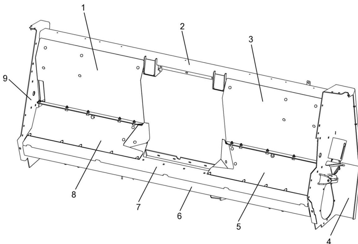
1, 3 – стенки; 2 – балка верхняя; 4, 9 – боковины; 5, 8 – поддоны; 6 – балка нижняя; 7 – поддон регулируемый
