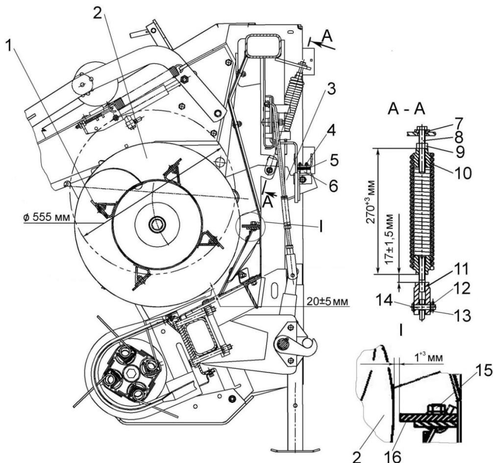
1 – лопатка; 2 – виток шнека; 3 – рычаг; 4, 9, 15 – гайки; 5 – компенсатор (пластины регулировочные); 6 – амортизатор; 7 – шайба сферическая; 8 – болт; 10 – пружина; 11 – вилка; 12 – шплинт; 13 – шайба; 14 – ось; 16 – чистик
