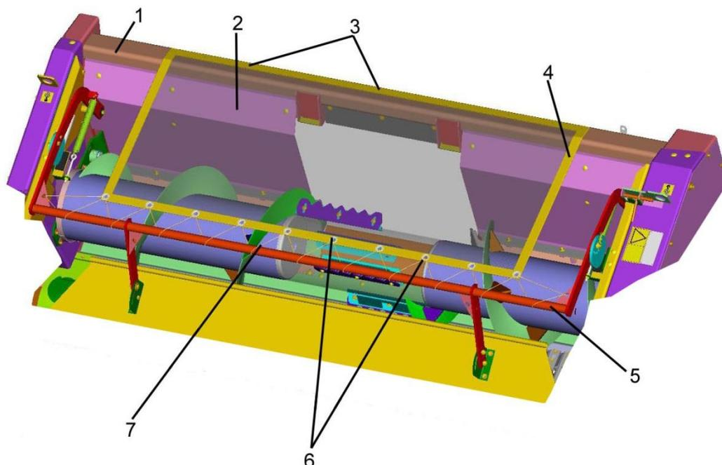
1 – верхняя балка рамы; 2 – сетка полимерная; 3 – болты; 4 – ткань тентовая; 5 – труба рамки прижимного устройства; 6 – отверстия армированные; 7 – шнур
