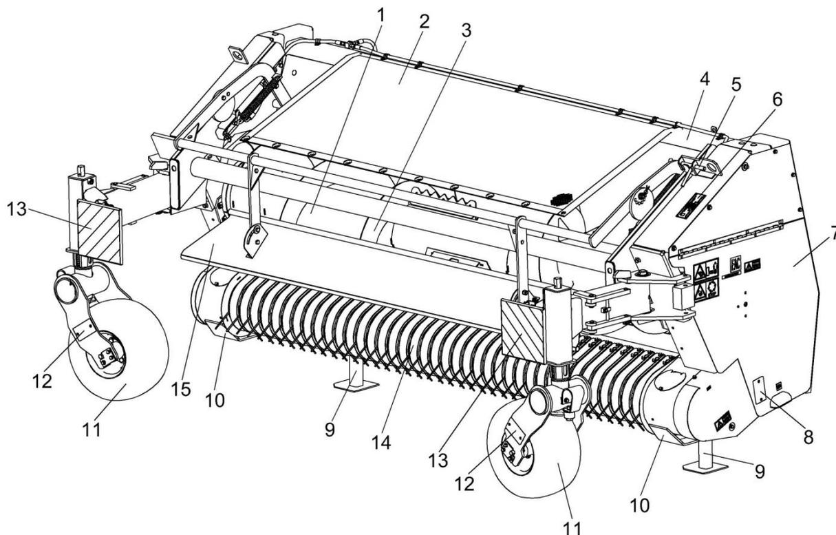
1 – шнек; 2 – защитный экран; 3 – лопатка шнека; 4 – рама; 5 – фиксатор; 6 – табличка фирменная; 7 – ограждение; 8, 12 – световозвращатели; 9 – опоры стояночные; 10 – башмаки; 11 – колеса флюгерные; 13 – щитки габаритные; 14 – устройство подбирающее; 15 – устройство прижимное
