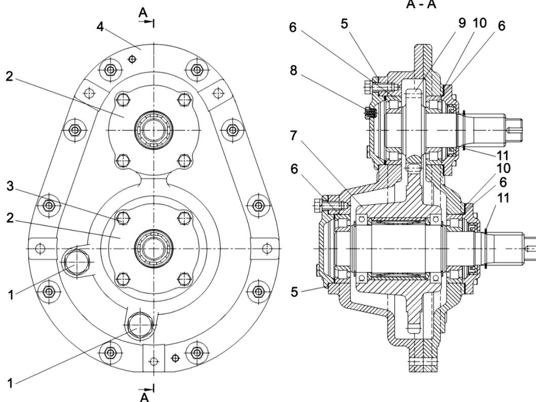
1 – пробки; 2 – крышки; 3 – болт; 4 – корпус; 5, 10 – прокладки; 6 – подшипники; 7 – муфта; 8 – клапан предохранительный; 9 – вал – шестерня; 11 – кольца
