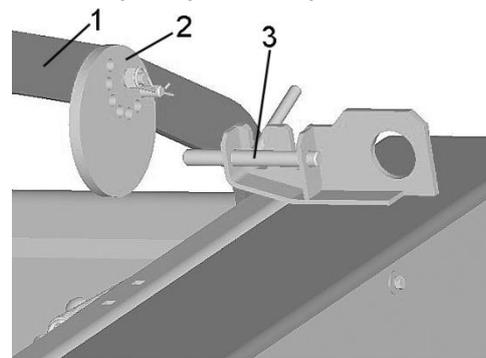
1 – рамка; 2 – диск эксцентриковый; 3 – фиксатор
