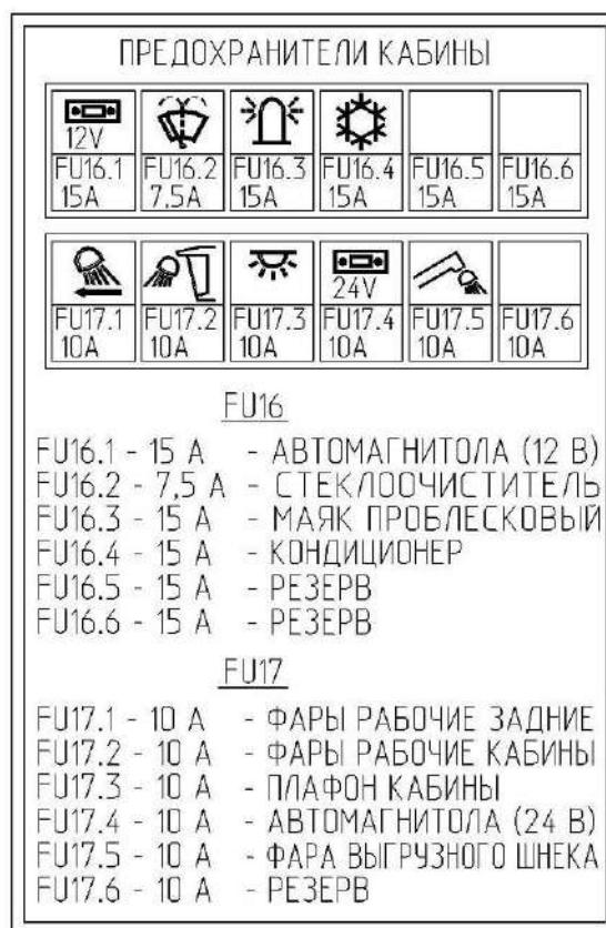
Рисунок 1.42 – Схема расположения предохранителей
