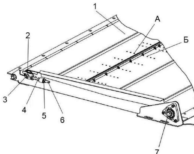
1 - лента транспортера; 3 - вал ведомый; 2, 4, 5 - гайка; 6 - винт; 7 - вал ведущий
