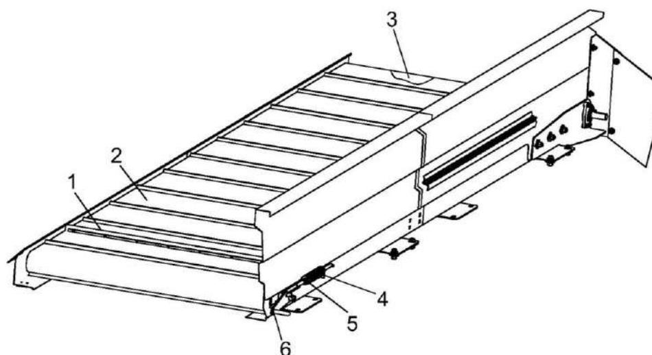
1 - планки; 2 – лента; 3, 6 - вальцы; 4 - пружина; 5 - гайки; 6 - планка
