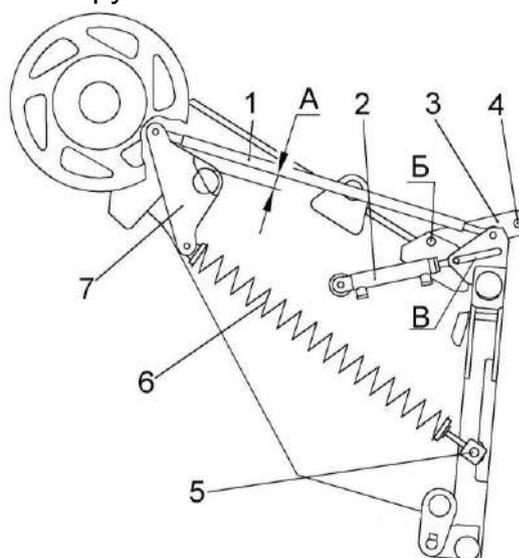
1 – тяга; 2 – гидроцилиндр; 3 – кронштейн; 4 – ось; 5 – шарнир; 6 – пружина; 7 – рычаг
