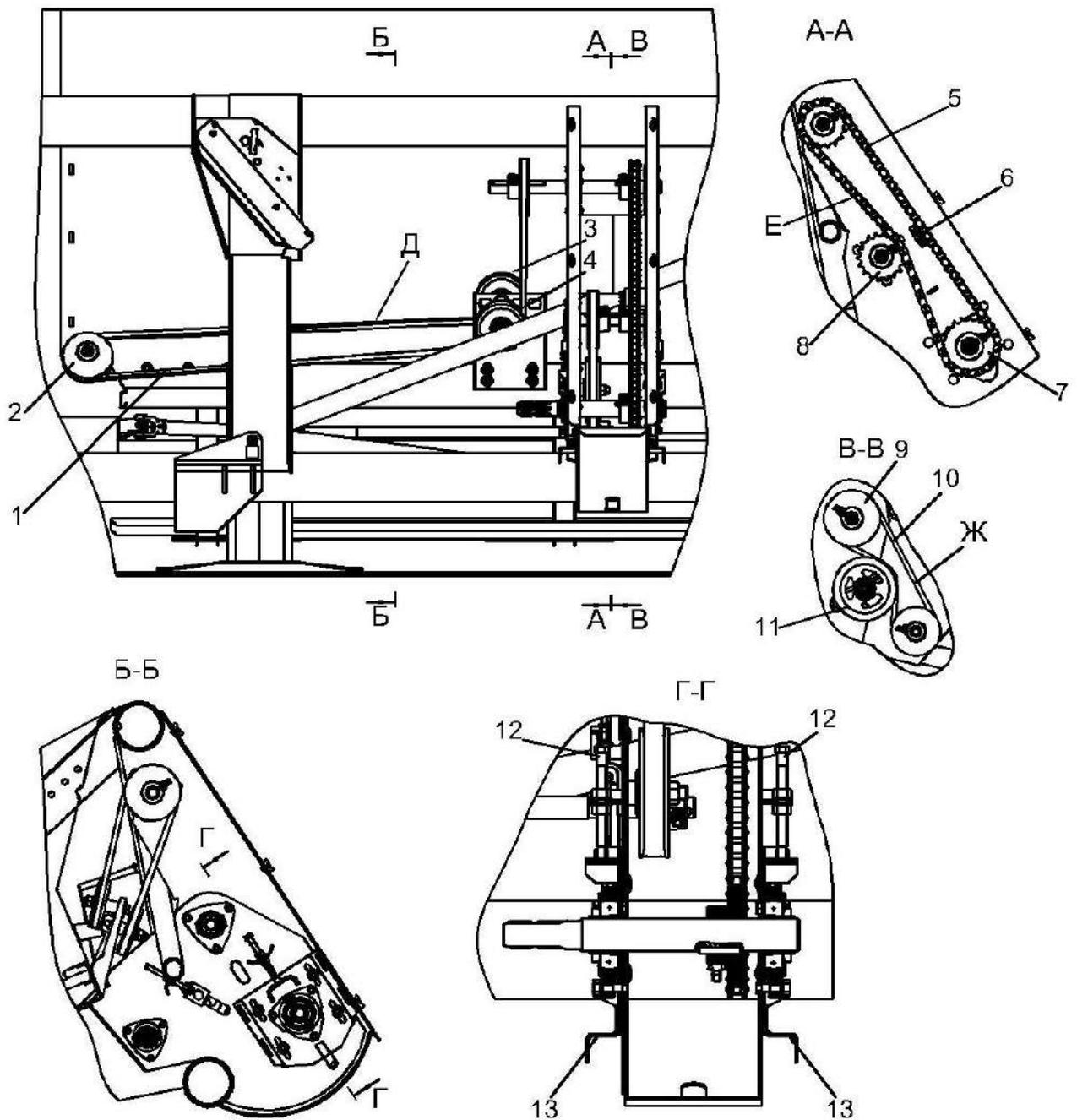
1, 10 - передачи ременные; 2, 3, 4, 9 - шкивы; 5 - цепная передача; 6 - успокоитель;
