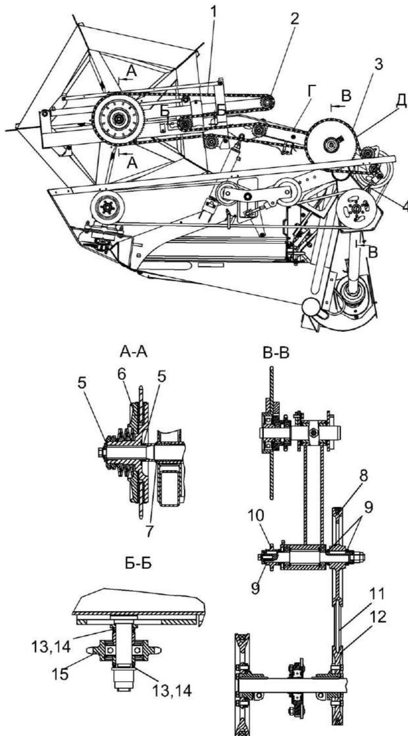
1, 3 - передачи цепные; 2 - устройство обводное; 4 - винт натяжной; 5 - кольцо; 6 - муфта фрикционная; 7 - шайба регулировочная; 8, 12 - шкивы; 9 - шайба специальная; 10, 15 - звездочки; 11 - передача ременная; 13 - шайбы; 14 - прокладки
