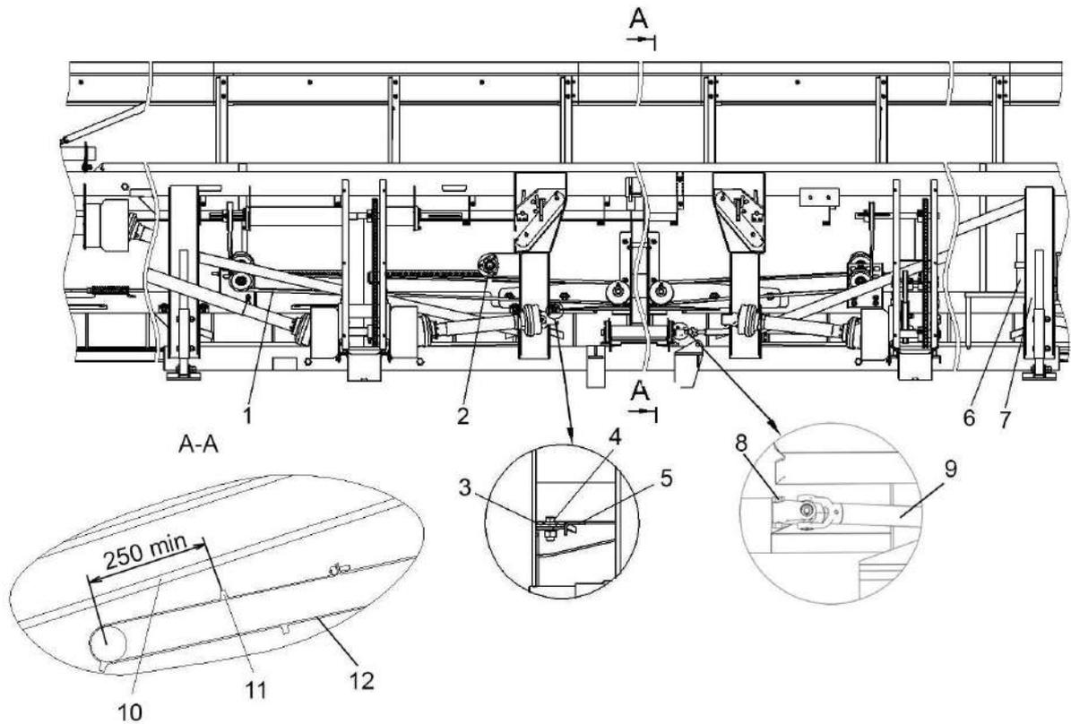
1 – ремень; 2 - хвостовик вала; 3 - пластина; 4 - болт; 5 - упор; 6 - рукоятка; 7 – стойка; 8 – болт; 9 – вал карданный; 10 – ребра поперечного транспортера; 11 – ребра продольного транспортера; 12 – лента продольного транспортера
