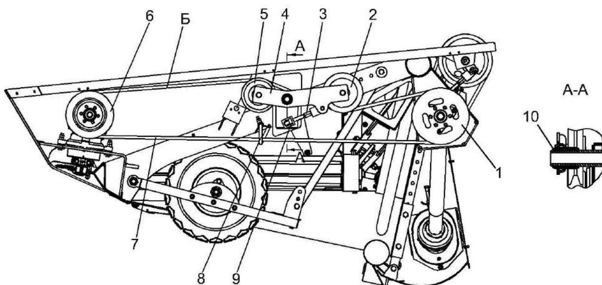
1, 2, 5, 6 - шкивы; 3 - винт натяжной; 4 - рычаг; 7 - передача ременная; 8 - успокоитель; 9 - кронштейн; 10 - шайба
