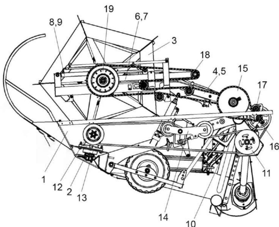
1 – рама; 2 – режущий аппарат; 3 – мотовило; 4,5 – поддержки; 6,7 – опоры; 8,9 – гидроцилиндры; 10 – ременная передача; 11 – ведущий шкив; 12 – ведомый шкив; 13 – редуктор; 14 – натяжное устройство; 15 – ведомая звездочка; 16 – ведущая звездочка; 17 – натяжная звездочка; 18 – обводное устройство; 19 – муфта
