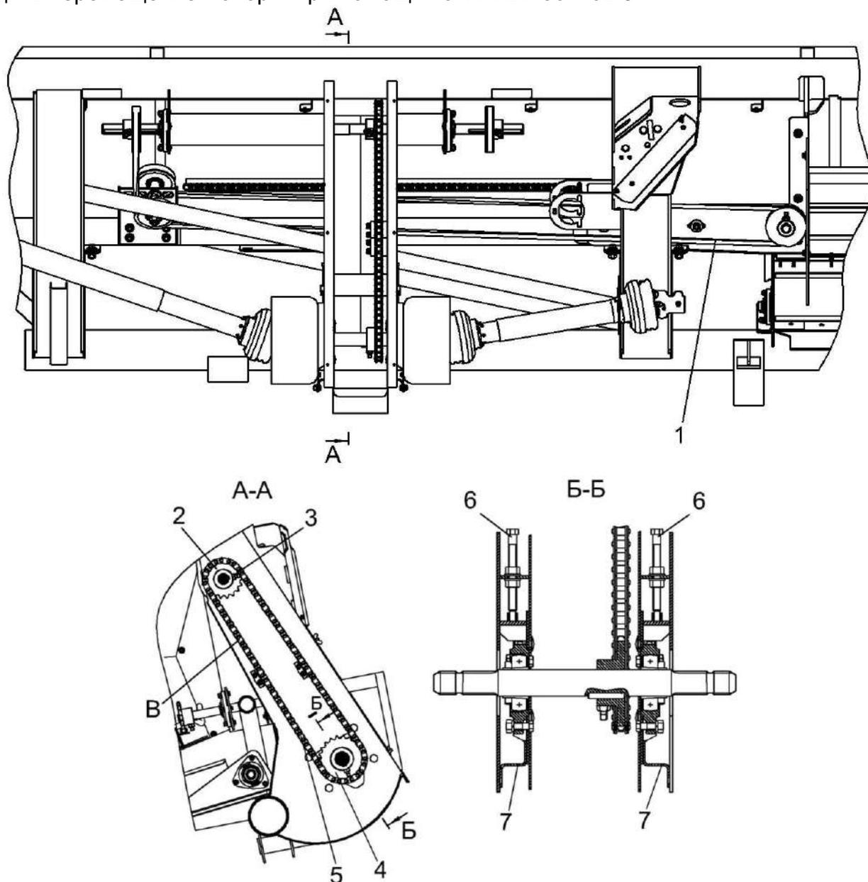
1 - передача ременная; 2, 4 - звездочки; 3 - винт; 5 - передача цепная; 6 - болты натяжные; 7 - опоры
