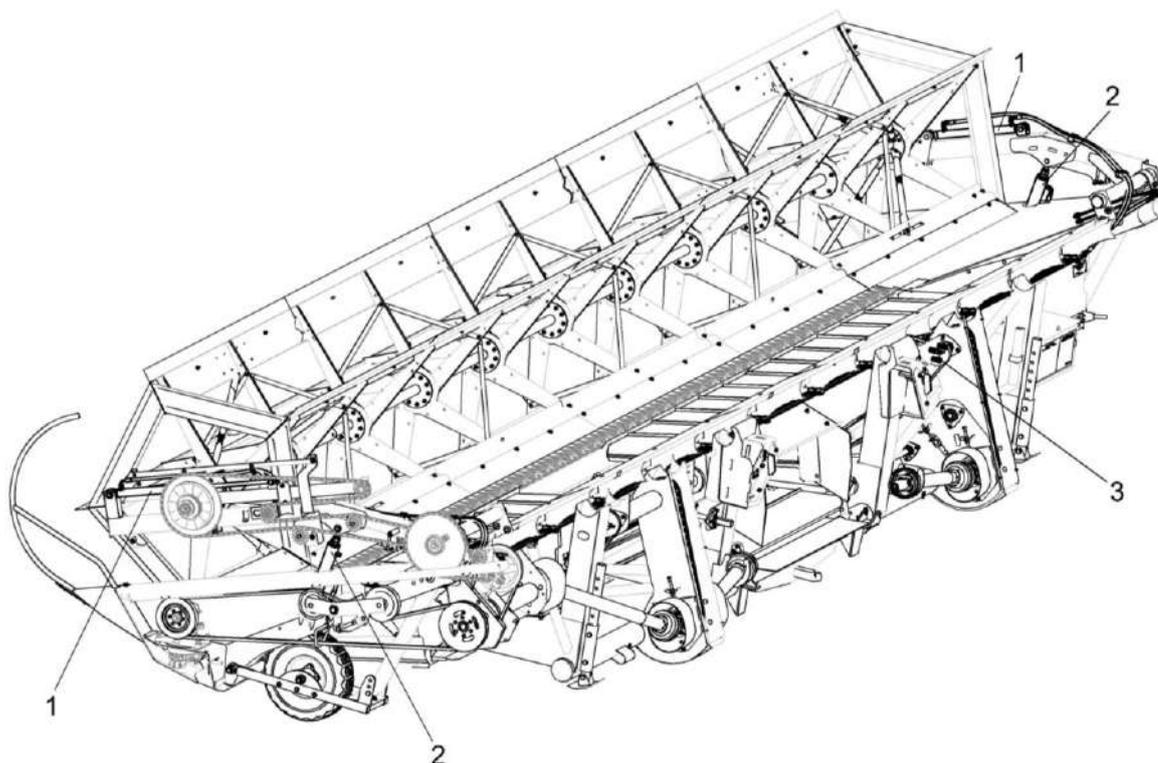
1 – гидроцилиндры горизонтального перемещения мотовила; 2 - гидроцилиндры вертикального перемещения мотовила; 3 - разъем гидравлический
