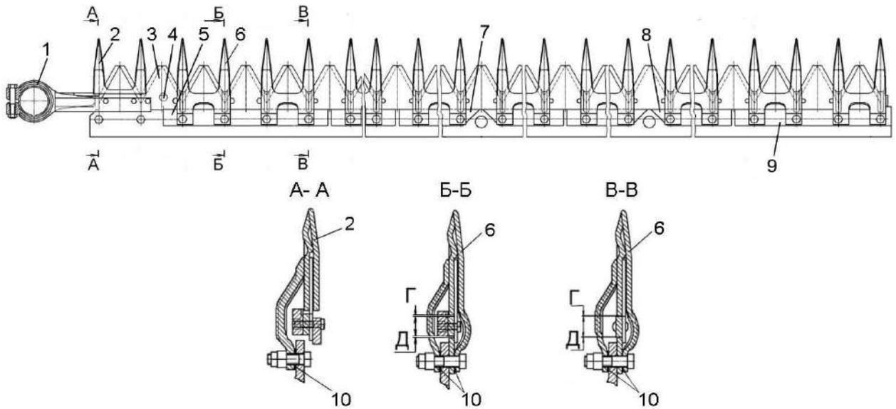
1 – головка ножа; 2 – палец направляющий; 3 – сегмент; 4 – полоса ножевая;
