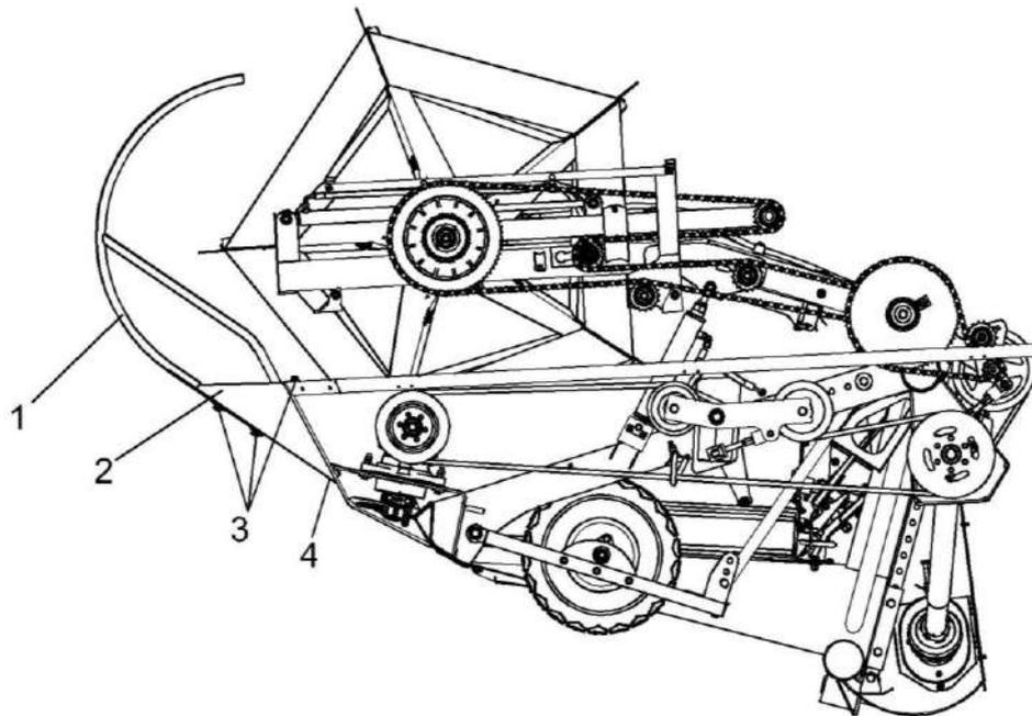
1 – прутковый делитель; 2 - носок; 3 - болт М12х25; 4 - болт М12х30
