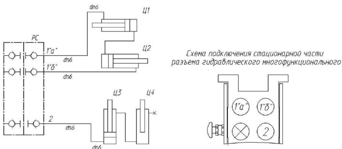
Рисунок 1.8 – Схема гидравлическая принципиальная гидросистемы жатки с многофункциональным разъемом
