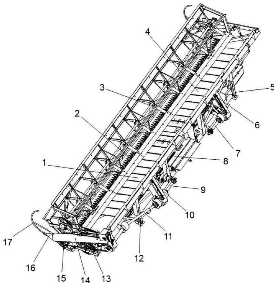
1 – транспортер поперечный левый; 2 - аппарат режущий; 3 – мотовило; 4 - транспортер поперечный правый; 5, 12 - стойки; 6 - привод правого транспортера; 7, 9, 11 - валы карданные; 8 – транспортер продольный; 10 – привод левого транспортера; 13 - колесо; 14 - рама; 15 - редуктор; 16 - носок; 17 - делители прутковые
