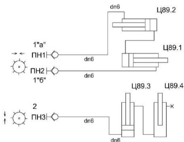
Ц89.1, Ц89.2 - гидроцилиндры горизонтального перемещения мотовила; Ц89.3, Ц89.4 - гидроцилиндры вертикального перемещения мотовила
