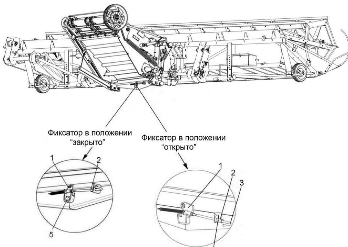
1 – поворотный язычок; 2 – втулка; 3 – фиксатор; 4 – кронштейн; 5 – центральный палец жатки
