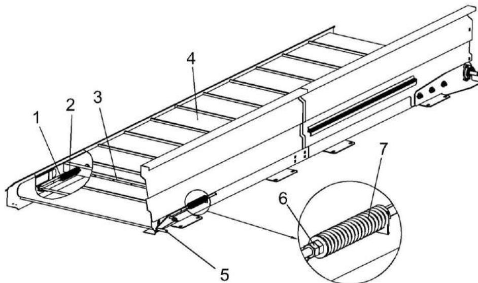
1, 6 - гайки; 2, 7 – пружины; 3 - планки; 4 - лента; 5 - рукоятка
