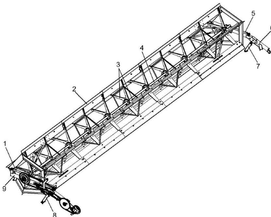
1, 5; 7, 8 – гидроцилиндры; 2 – планка мотовила; 3 – лучи; 4 – вал; 6, 9 – поддержки
