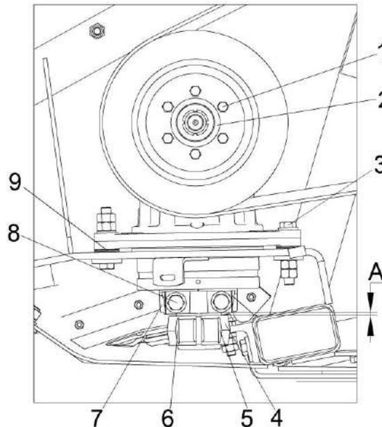
1 – винт крепления шкива; 2 – центральная гайка; 4 – головка ножа; 5 – гайка; 6, 8, 3 – болты; 7 – водило; 9 – регулировочные прокладки;
