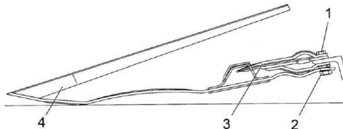
1 – стеблеподъемник; 2 – палец режущего аппарата; 3 – контргайка; 4 – болт крепления стеблеподъемника
