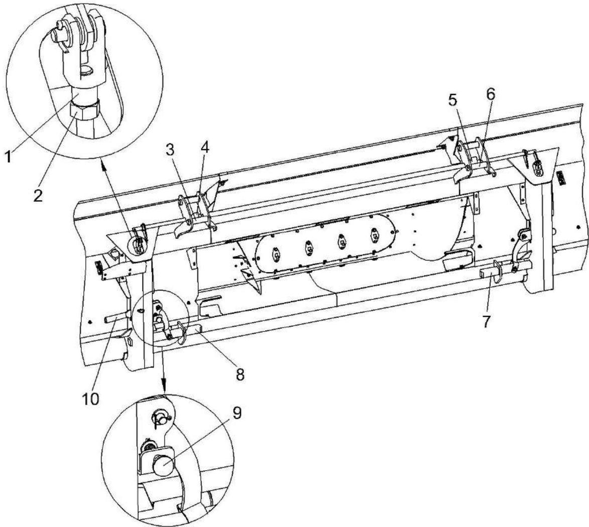
1 - тяга левая; 2 - контргайка; 3, 6 – ловители; 4, 5 - кулачки; 7, 8 – фиксаторы; 9 - фиксатор подпружиненный; 10 - рукоятка
