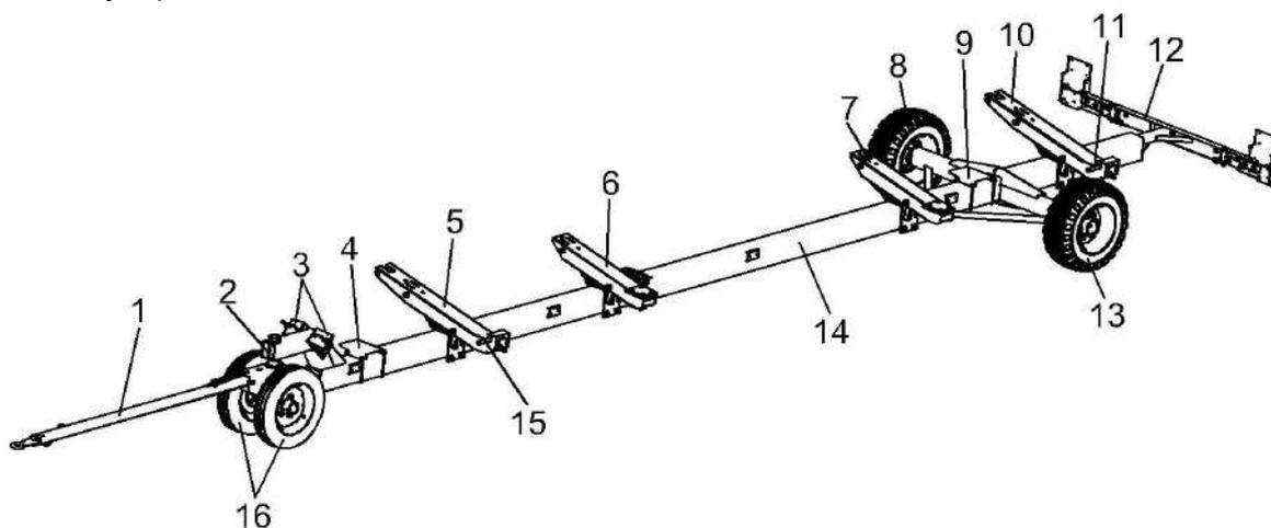
1 – дышло; 2 – ось передняя; 3 - упоры противооткатные; 4, 9 - упоры; 5, 6, 7, 10 - ложементы; 8, 13, 16 - колеса; 11, 15 - фиксаторы; 12 - балка габаритная; 14 - рама тележки
