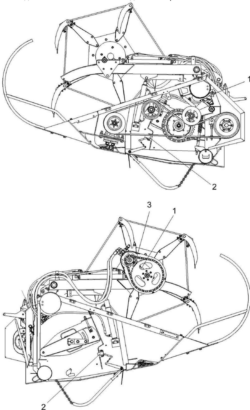
1 – датчик выноса мотовила; 2 - датчик положения копиров; 3 - датчик оборотов мотовила
