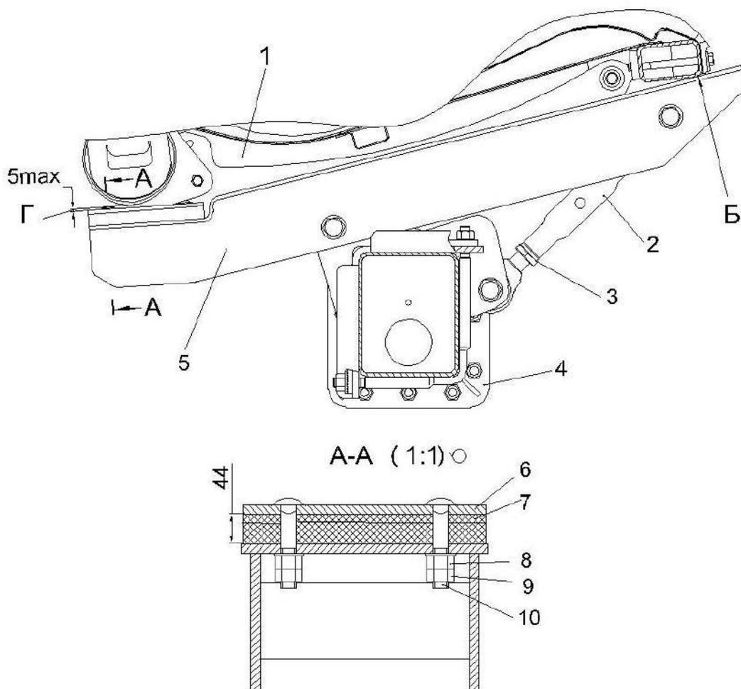
1 – жатка; 2- тяга; 3, 8, 9 - гайки; 4- тележка транспортная; 5 – ложемент; 6 – пластина;
