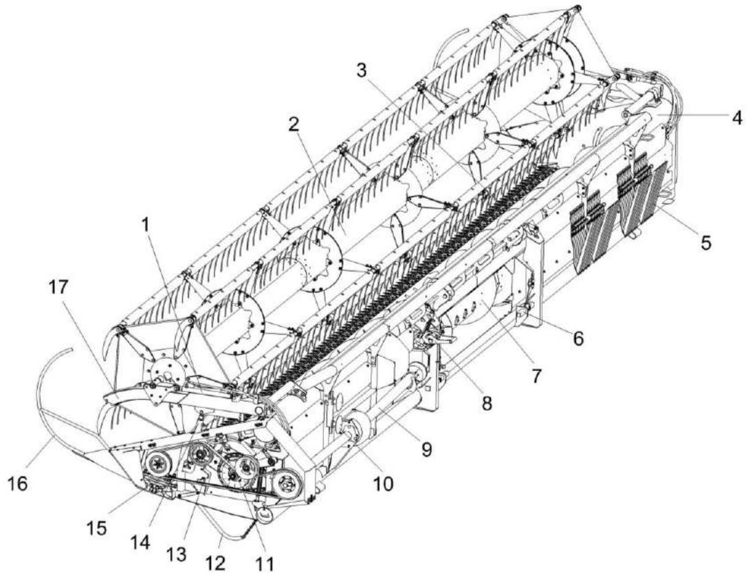
1 – гидроцилиндр выноса мотовила; 2 – мотовило; 3 – режущий аппарат; 4 – рама жатки; 5 - стеблеподъемники; 6 - механизм фиксации; 7 – шнек; 8 – гидросистема жатки; 9 - опоры стояночные; 10 - вал карданный; 11 - привод жатки; 12 - копирная дуга; 13 - установка датчиков; 14 – гидроцилиндр подъема мотовила по высоте; 15 – угловая передача; 16 - делитель прутковый; 17 – поддержка мотовила
