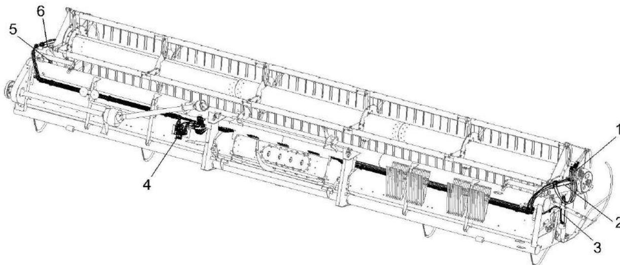
1 – гидромотор привода мотовила; 2, 3, 5, 6 - гидроцилиндры перемещения мотовила;
