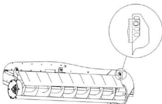
Рисунок 2.11 – Регулировка ограждения над горизонтальным шнеком бункера
