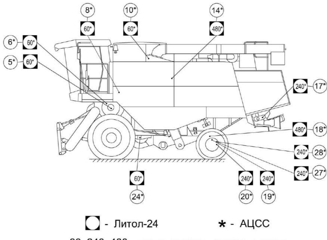
Рисунок 3.3 – Схема смазки комбайна с АЦСС (вид слева)
