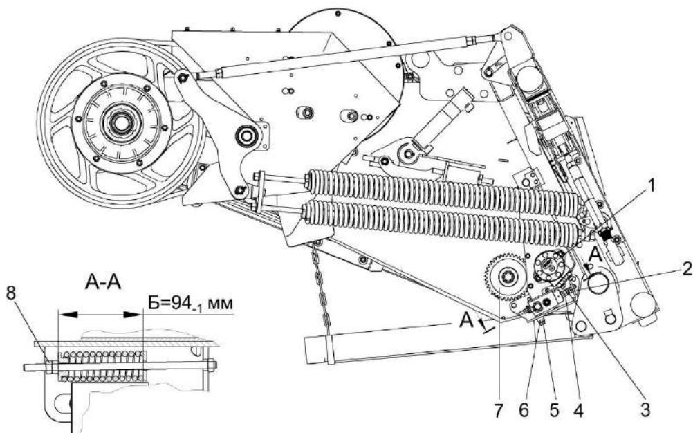
1 – гидрореверс; 2, 5 – болты; 3, 8 – гайки; 4 – плунжер; 6 – эксцентрик; 7 – колесо
