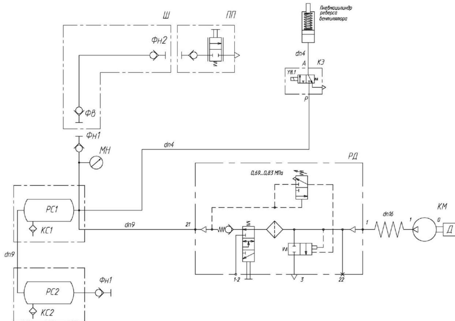
КМ – компрессор; КЭ – клапан электромагнитный; КС1, КС2 – клапаны слива конденсата, МН - манометр; ПП – пневмопистолет обдувочный; РД – регулятор давления; РС1, РС2 - ресиверы; Фв, ФН1, ФН2 - фитинги; Ш – шланг
