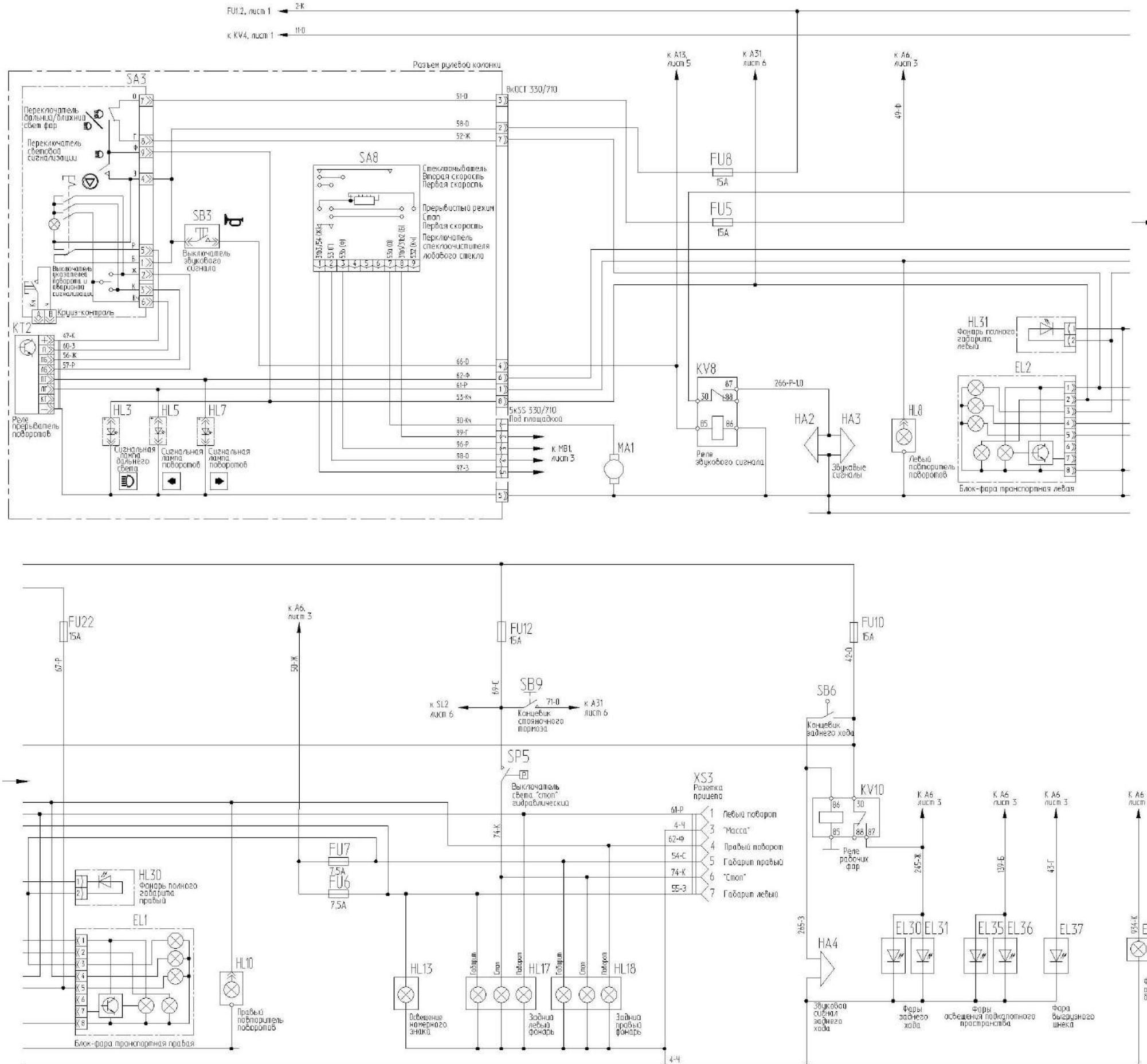
Рисунок Б.2 – Схема электрическая принципиальная комбайна (лист 2)
