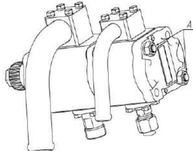
Рисунок 4.1 – Демонтаж гидронасоса
