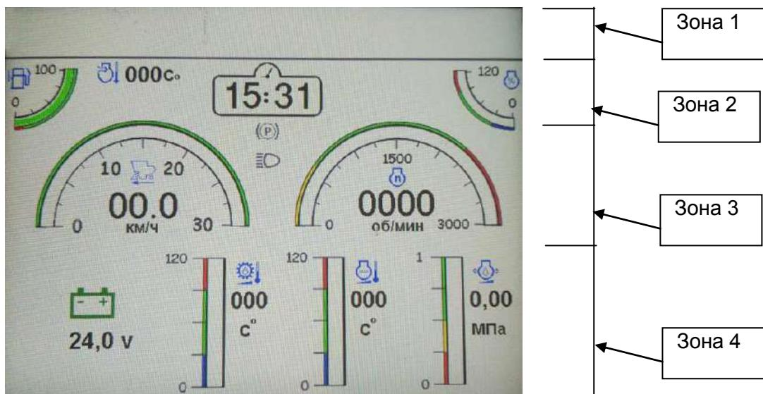
Рисунок Ж.4 – Экран транспортного режима
