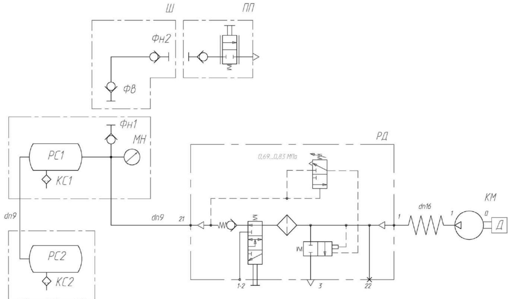
КМ – компрессор; КС1, КС2 – клапаны слива конденсата; МН - манометр; ПП – пневмопистолет обдувочный; РД – регулятор давления; РС1, РС2 - ресиверы; ФВ, Фн1, Фн2 - фитинги; Ш,ШН – шланг
