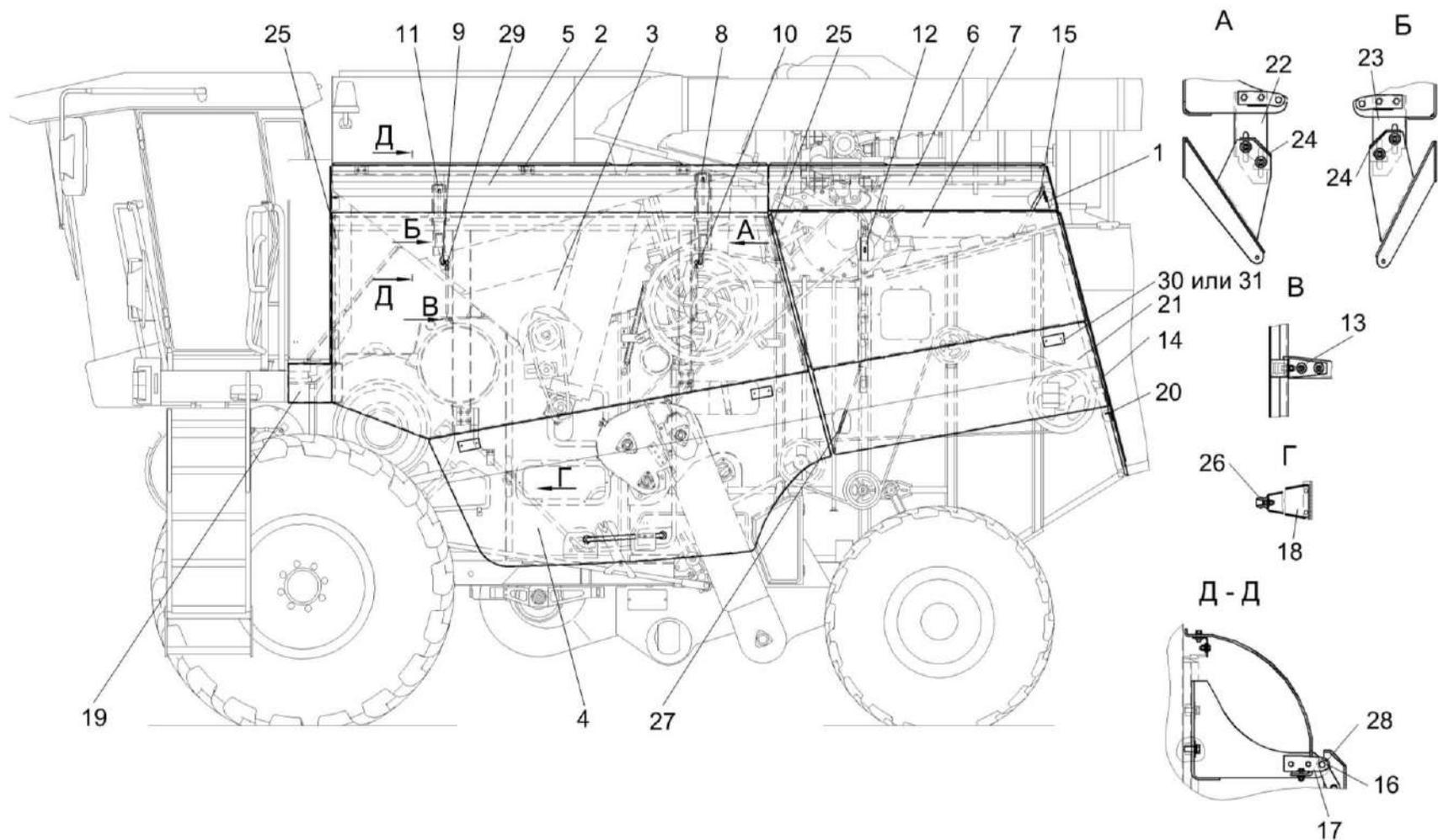
Рисунок 1 – Установка капотов и ограждения КЗК-12-0128500А-01 (вид слева)
