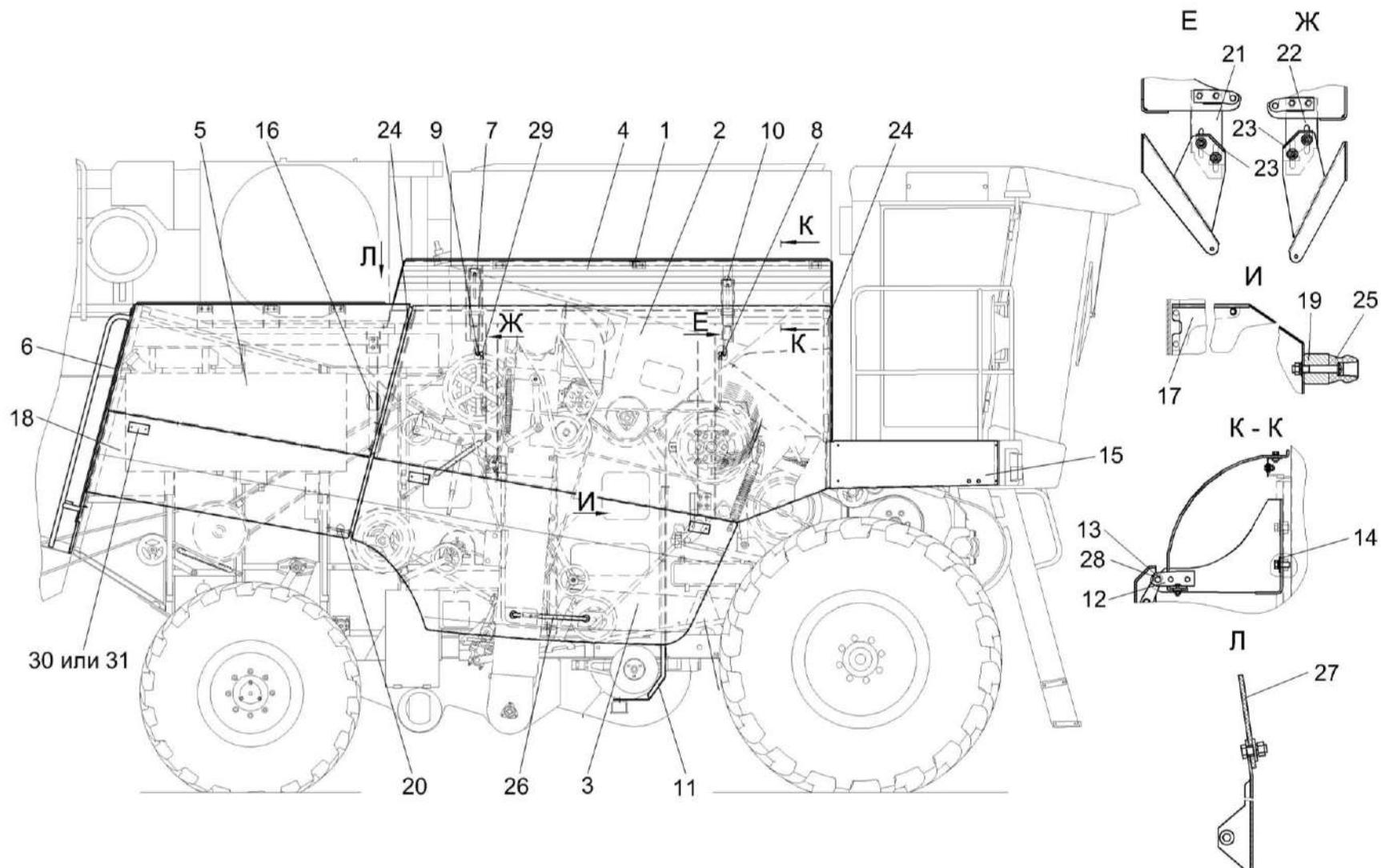
Рисунок 2 – Установка капотов и ограждения КЗК-12-0128500А-01 (вид справа)
