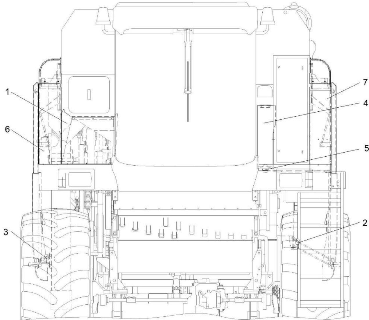
Рисунок 3 – Установка капотов и ограждения КЗК-12-0128500А-01 (вид спереди)
