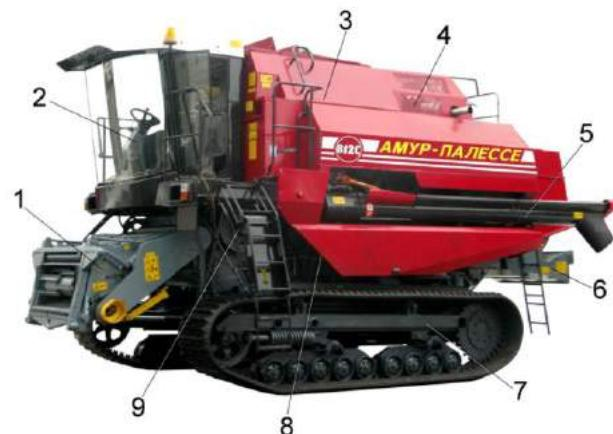
1 – наклонная камера, 2 – кабина с площадкой управления; 3 - бункер; 4 – установка двигателя; 5 – шнек выгрузной; 6 – соломоизмельчитель с дефлектором, 7 - шасси; 8 - очистка; 9 – молотильный аппарат
