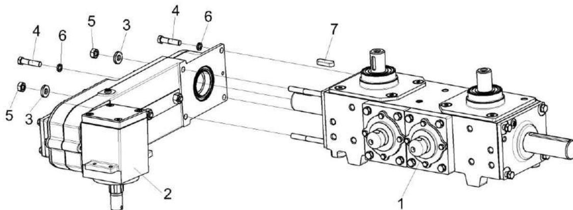
Рисунок 39 – Привод КПС-4-0518200-01
