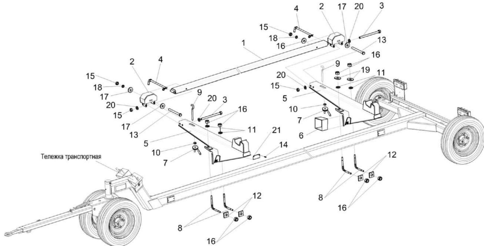
Рисунок 49 – Установка монтажных изделий на тележку транспортную
