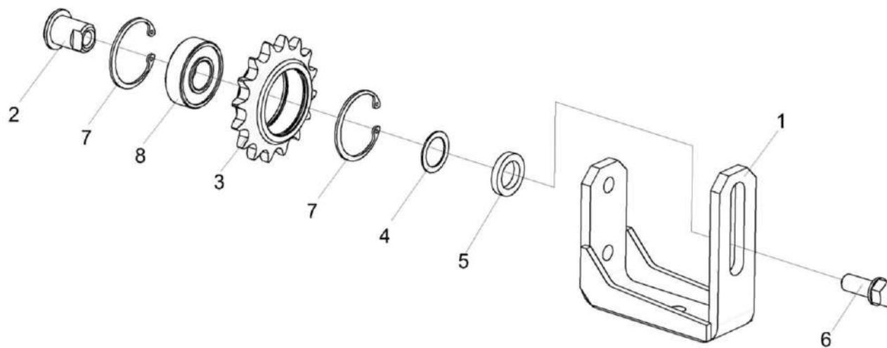
Рисунок 25 – Устройство натяжное КПС-4-0523000
