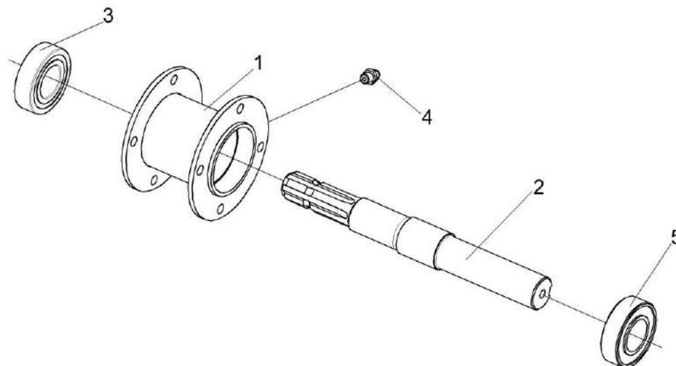
Рисунок 24 – Контрпривод 1.320.193
