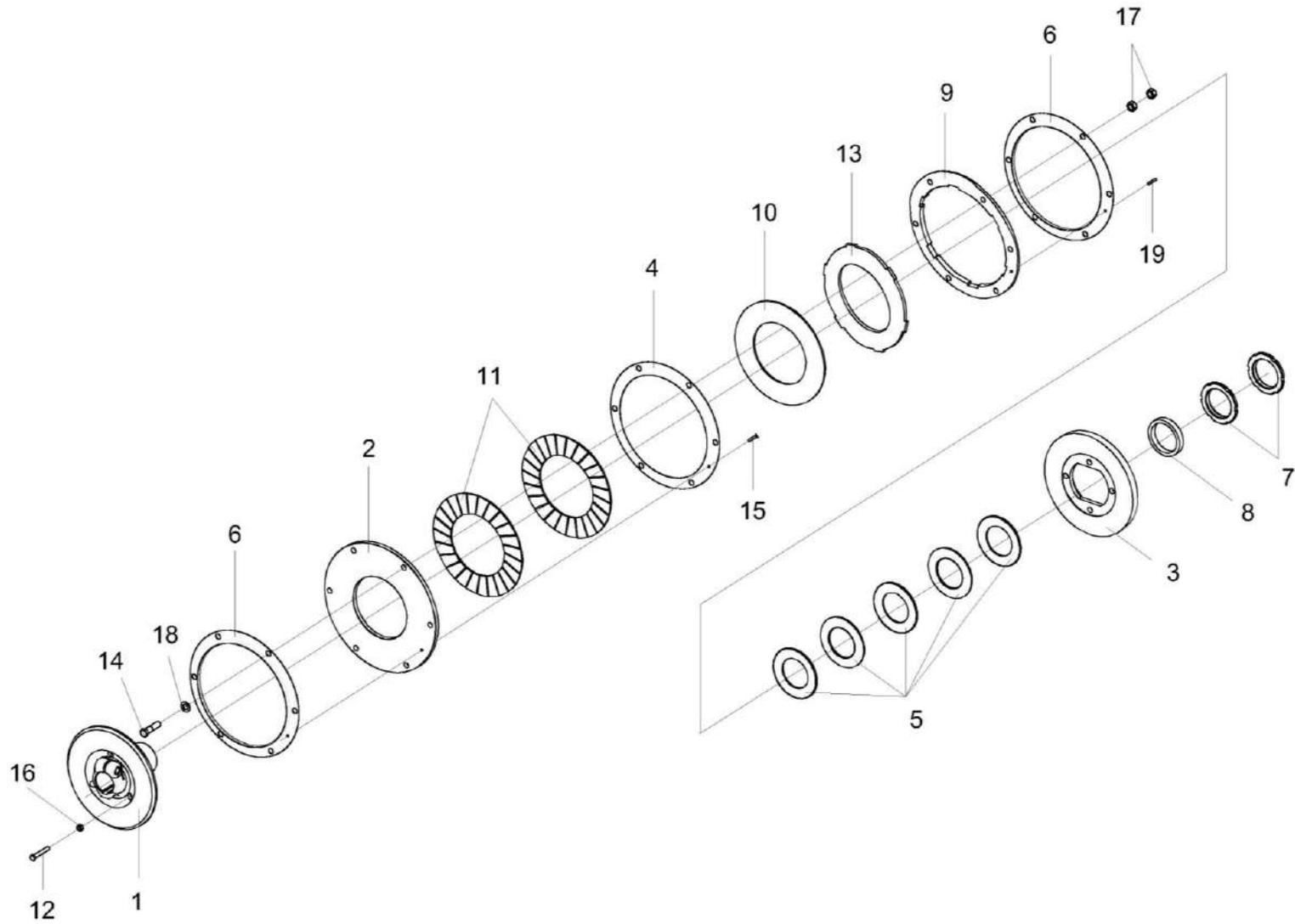
Рисунок 4 – Муфта предохранительная КЗК-10-0502100
