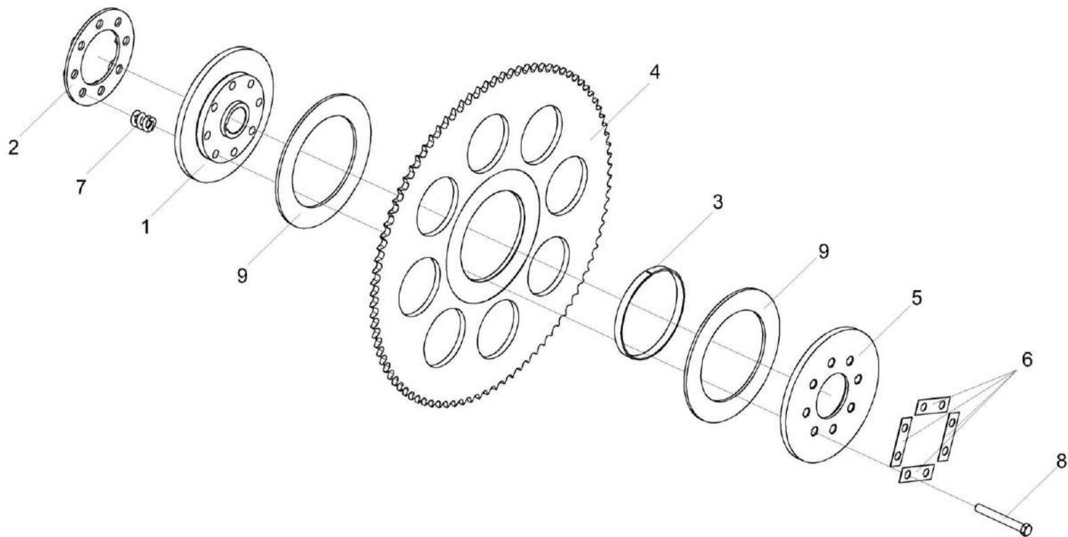
Рисунок 23 – Муфта предохранительная КПС-5-0502040
