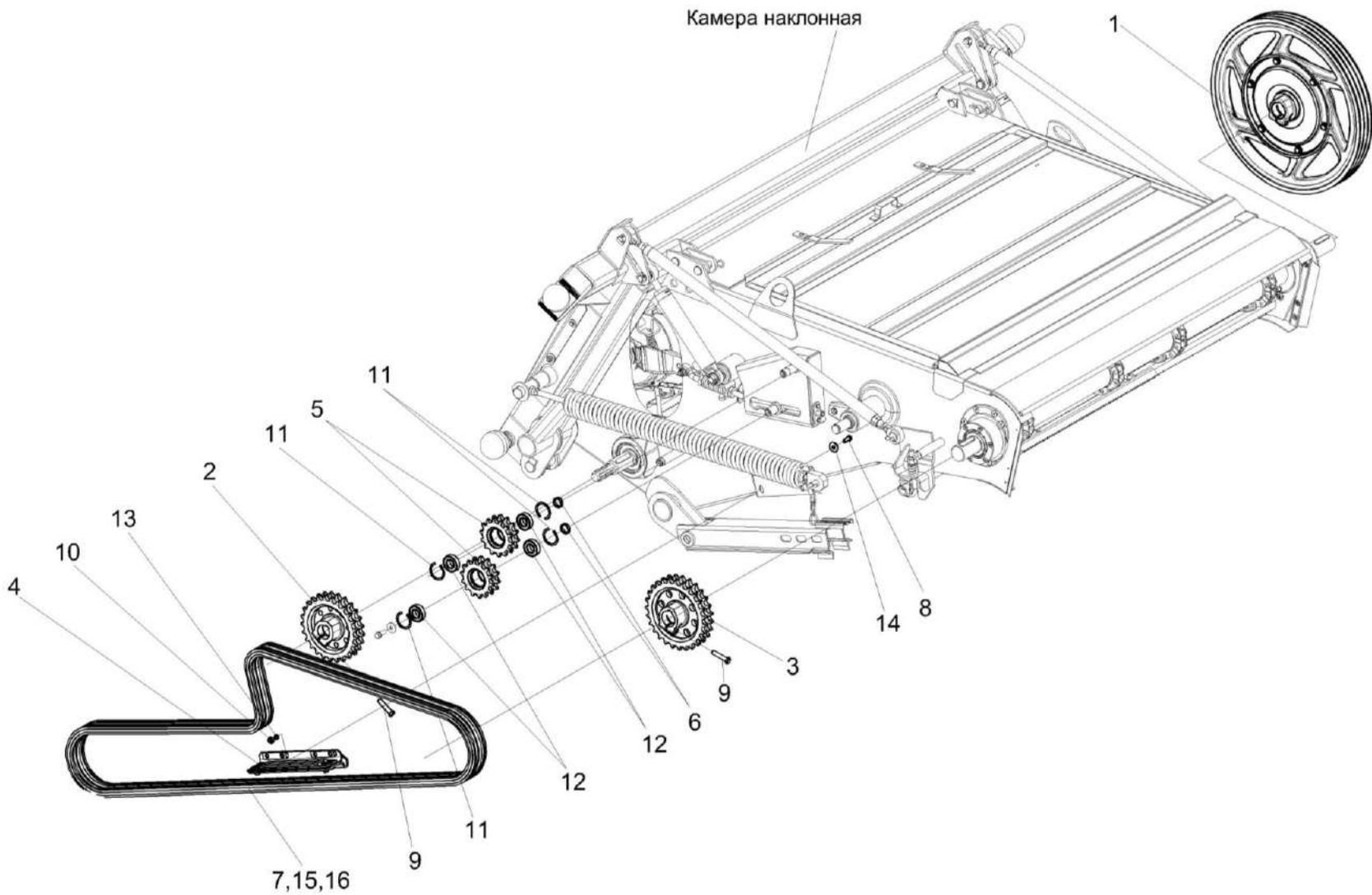
Рисунок 3 – Установка монтажных изделий на камеру наклонную
