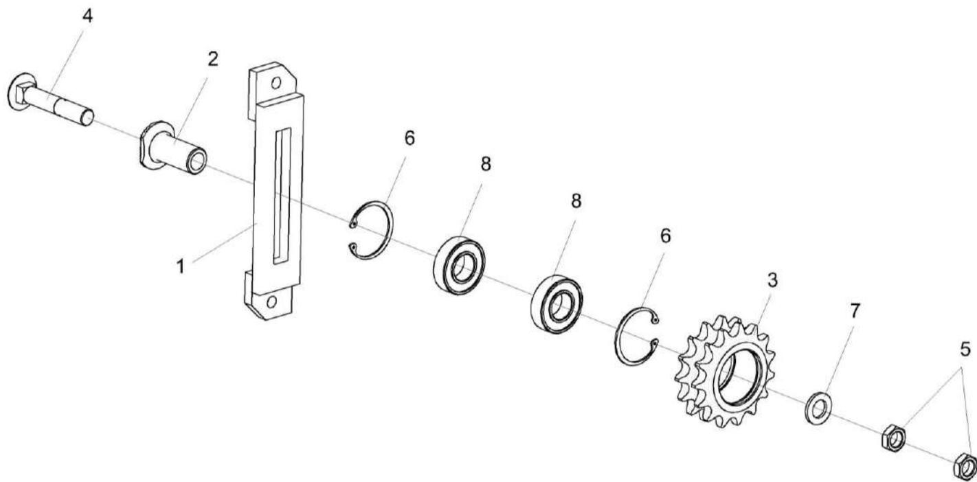
Рисунок 29 – Устройство натяжное КП-6-0524000
