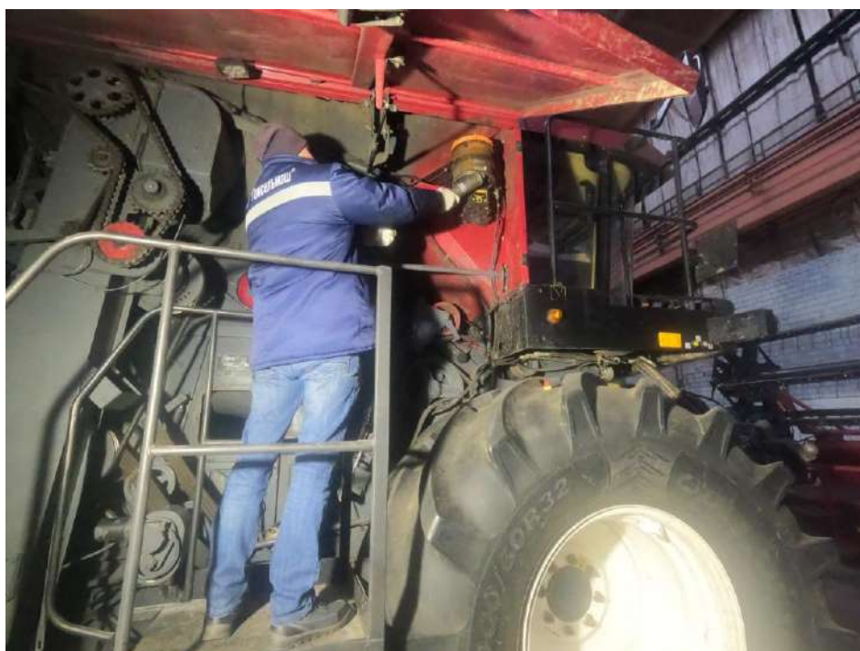
Рисунок 3.4 – Лестница с площадкой для заправки насоса АЦСС
