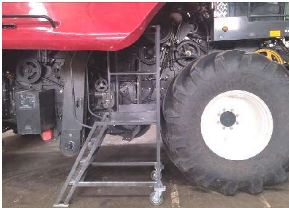
Рисунок 3.4 – Лестница с площадкой для заправки насоса АЦСС
