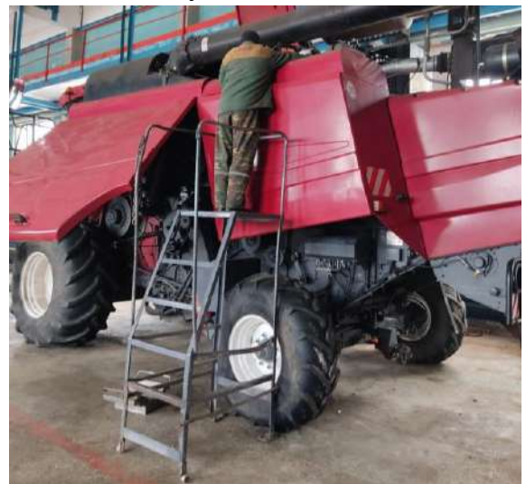
Рисунок 3.13 – Вид на лестничную площадку с оператором при замене всасывающего фильтроэлемента
