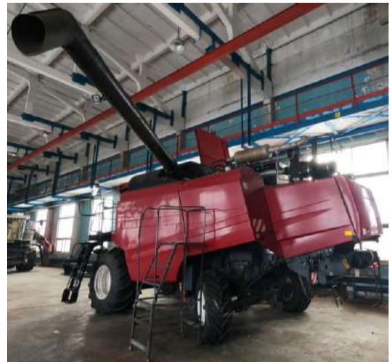
Рисунок 3.12 – Вид на трубу выгрузного шнека повернутую на угол не менее 50^\circ
