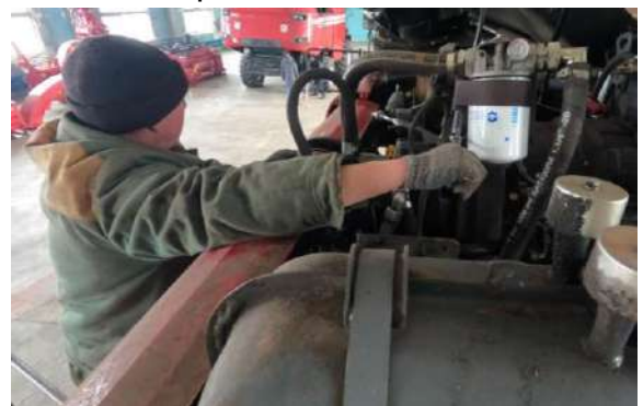
Рисунок 3.14 – Вид на демонтаж всасывающего фильтроэлемента с использованием ключа фильтра
