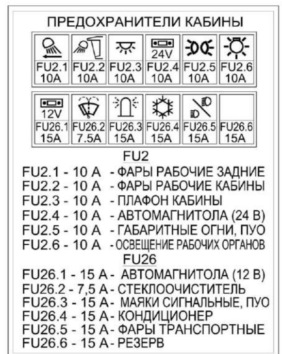
Рисунок 1.37 – Схема расположения предохранителей
