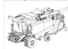
приблизительно под углом  $30^\circ$  -  $45^\circ$  справа налево, например см. рисунок . Если данное расположение затрудняет показ всех составных частей сборочной единицы, тогда комбайн разворачивают в более удобное положение, а на рисунке указывают
