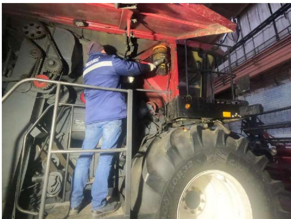
Рисунок 3.4 – Заправка насоса АЦСС
