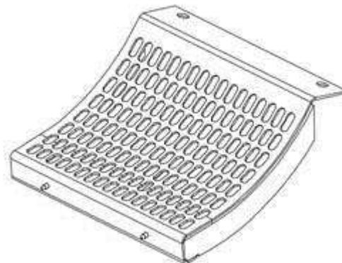
Рисунок 1.9 – Пробивная дека
