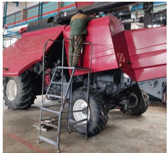
Рисунок 3.12 – Вид на лестничную площадку с механизатором при замене всасывающего фильтроэлемента
