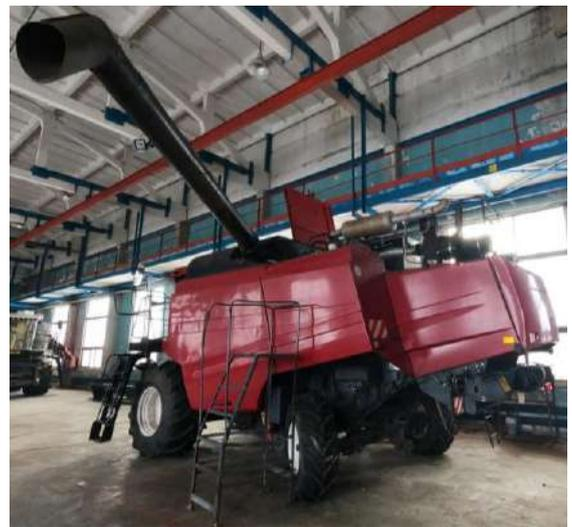
Рисунок 3.11 – Вид на трубу выгрузного шнека повернутую на угол не менее 50°
