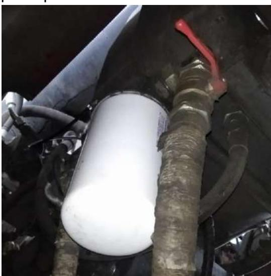
Рисунок 3.9 – Вид на перекрытый кран сливного фильтроэлемента
