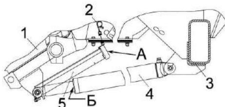
1 – питательно-измельчающий аппарат; 2 – пружина; 3 - балка моста; 4 – гидроцилиндр;
