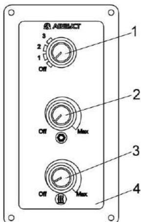
1 – ручка управления вентилятором; 2 – ручка управления терmostатом кондиционера; 3 – ручка управления отопителем; 4 – блок управления
