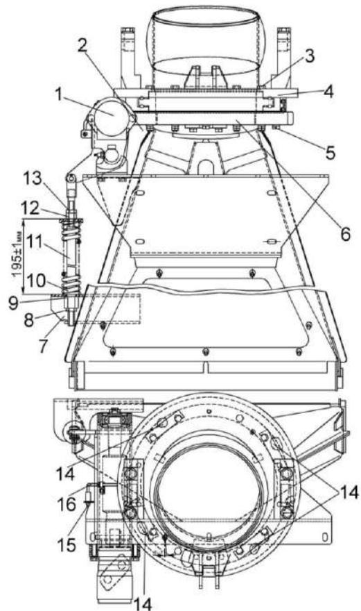
1 – червяк; 2 – корпус; 3, 5 – болты; 4 – фланец; 6 – колесо червячное; 7 – кронштейн; 8, 13 – контргайки; 9 - упор; 10 – пружина; 11 – направляющая; 12 – гайка; 14 – прокладки регулировочные; 15 - масленка, 16 – трубопровод подвода смазки
