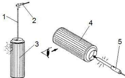
1 – трубка; 2 - пневмопистолет; 3,4 – основной фильтрующий элемент; 5– лампа
