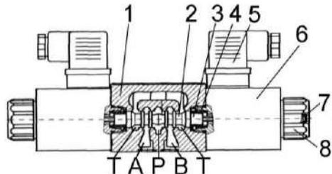
1 – корпус; 2 – золотник; 3 – толкатель; 4 – пружина; 5 – штепсельный разъем; 6 – катушка электромагнита; 7 – аварийная (контрольная) кнопка; 8 – гайка
