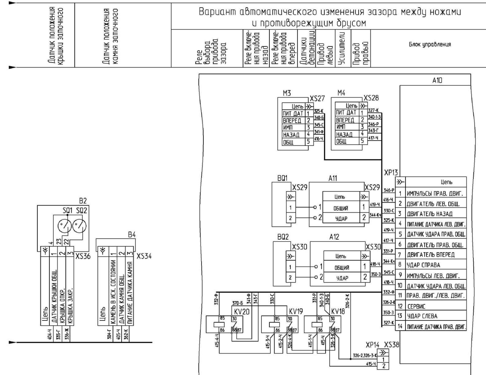
Рисунок Б.5 – Схема электрическая принципиальная комплекса (лист 3)
