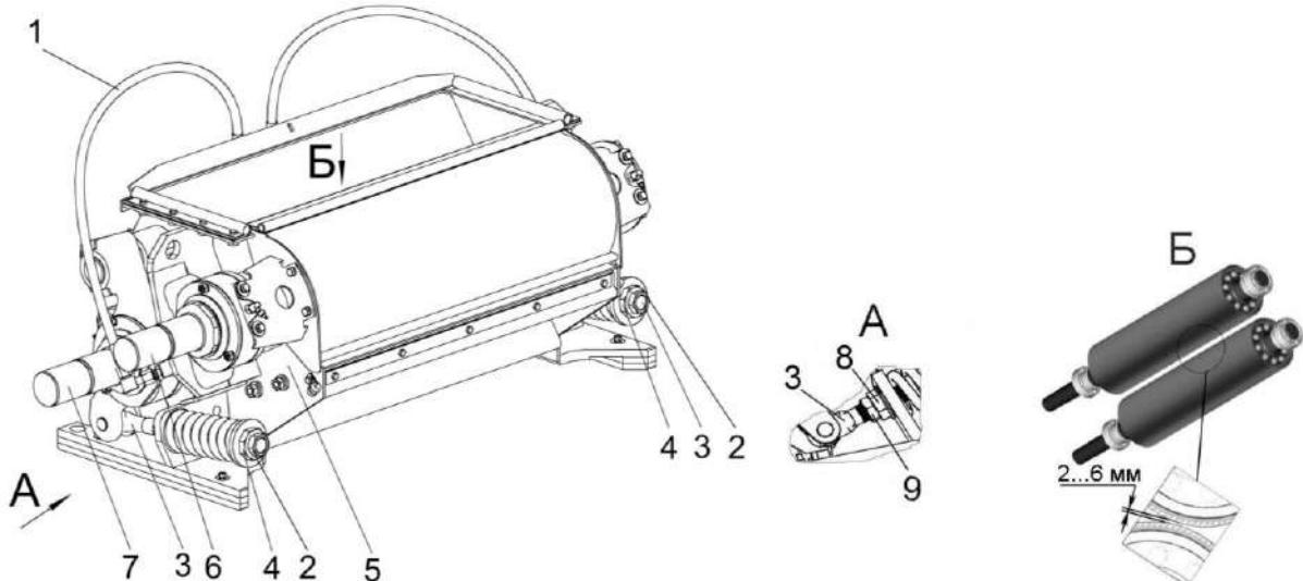
1 – гидросистема регулировки зазора; 2, 9 – гайки; 3 – тяга; 4 – гильза; 5 – корпус; 6 – валец верхний; 7 – валец нижний; 8 – упор
