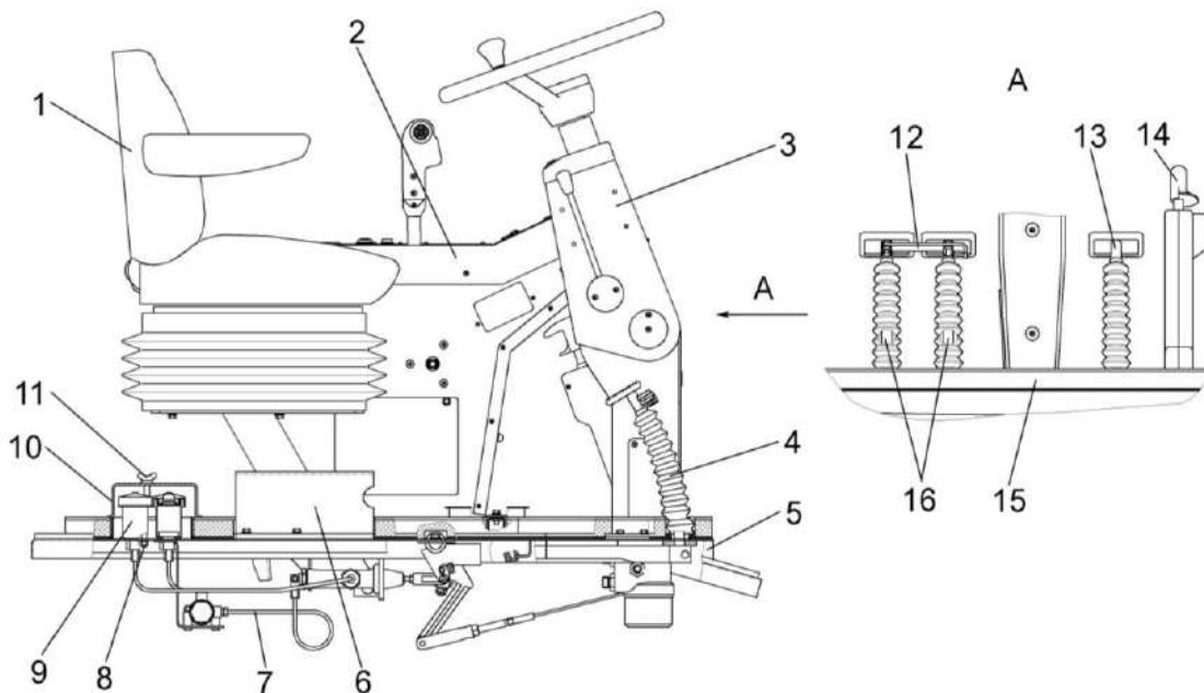
1 – сиденье; 2 – пульт управления; 3 – рулевая колонка; 4 – чехол; 5 – площадка; 6 – кронштейн сиденья; 7 – трубопровод; 8 – шпилька; 9 – бачок главного цилиндра тормоза; 10 – крышка; 11 – гайка; 12 – пластина; 13 – педаль управления блокировкой коробки диапазонов; 14 – рукоятка стояночного тормоза; 15 – коврик; 16 – педали управления тормозами
