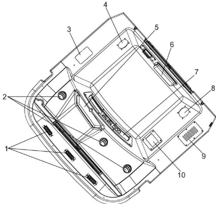
1, 2 – дефлекторы; 3 – плафон освещения кабины; 4, 8 – динамик автомагнитолы; 5 – крышка охлаждаемого бокса; 6 – панель задняя; 7 – панель передняя; 9 – решетка фильтра рециркуляции воздуха; 10 – панель управления климатической установкой
