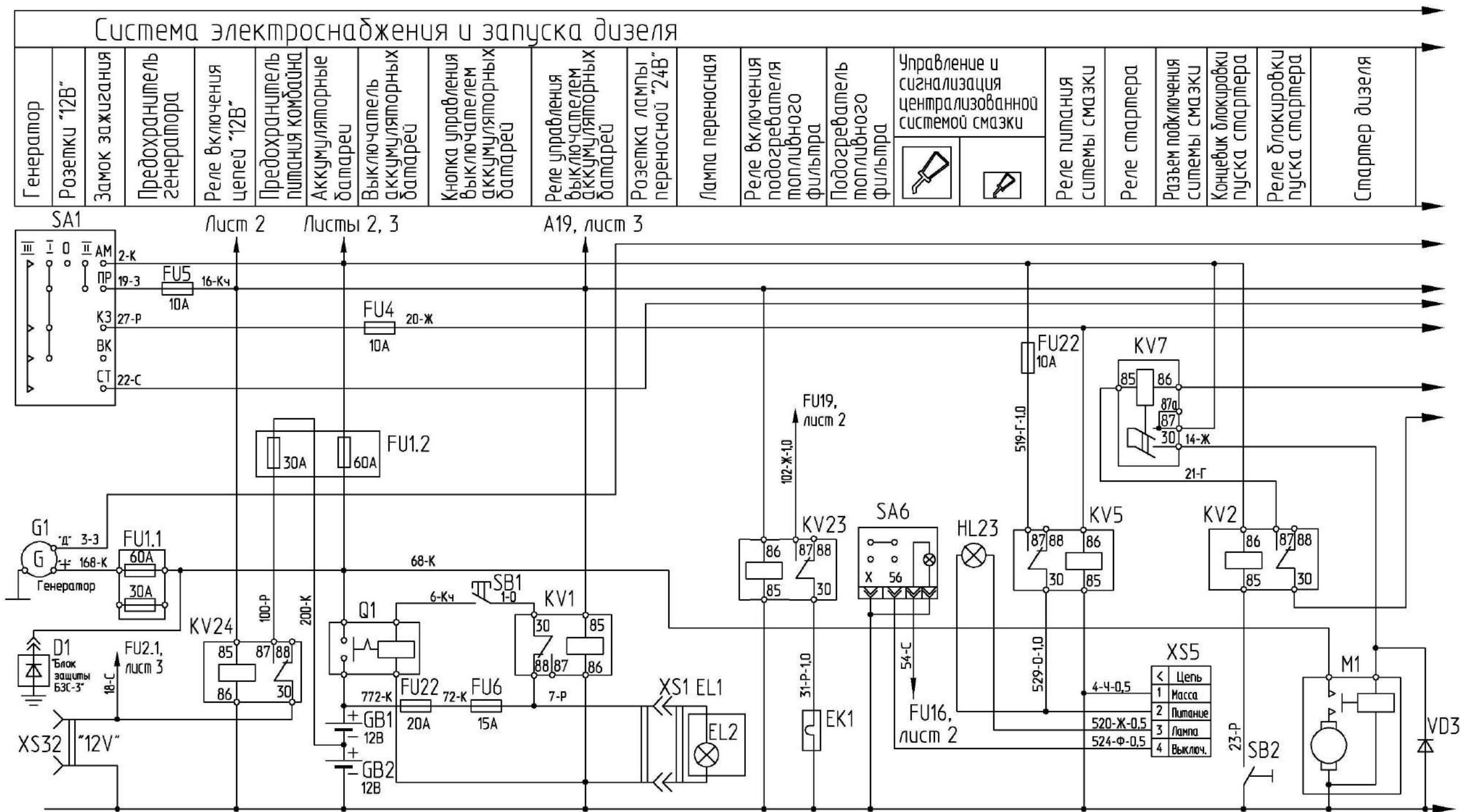
Рисунок Б.1 – Схема электрическая принципиальная комплекса (лист 1)
