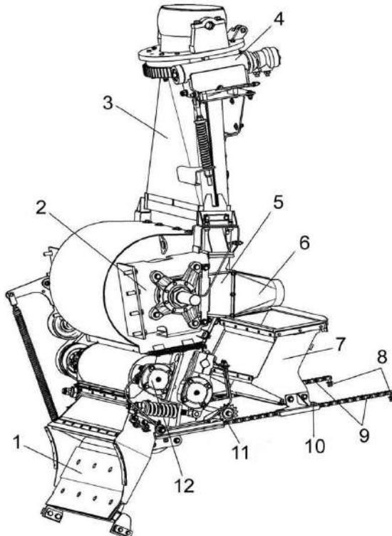
1 – камера приемная; 2 – ускоритель выброса; 3 – основание силосопровода; 4 – механизм поворота силосопровода; 5 – воздуховод; 6 – переходник; 7 – проставка; 8, 10 – болты; 9 – цепь; 11 – механизм перемещения; 12 - устройство доизмеряющее
