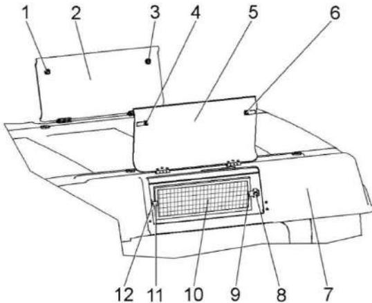
1, 3, 4, 6 – фиксаторы; 2, 5 – крышки; 7 – крыша кабины; 8, 12 – болты; 9, 11 – прижимы; 10 – фильтроэлемент
