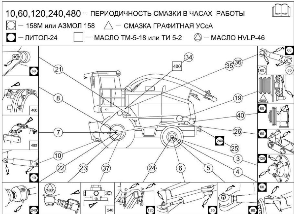
Рисунок 3.12 – Схема смазки измельчителя (вид слева)
