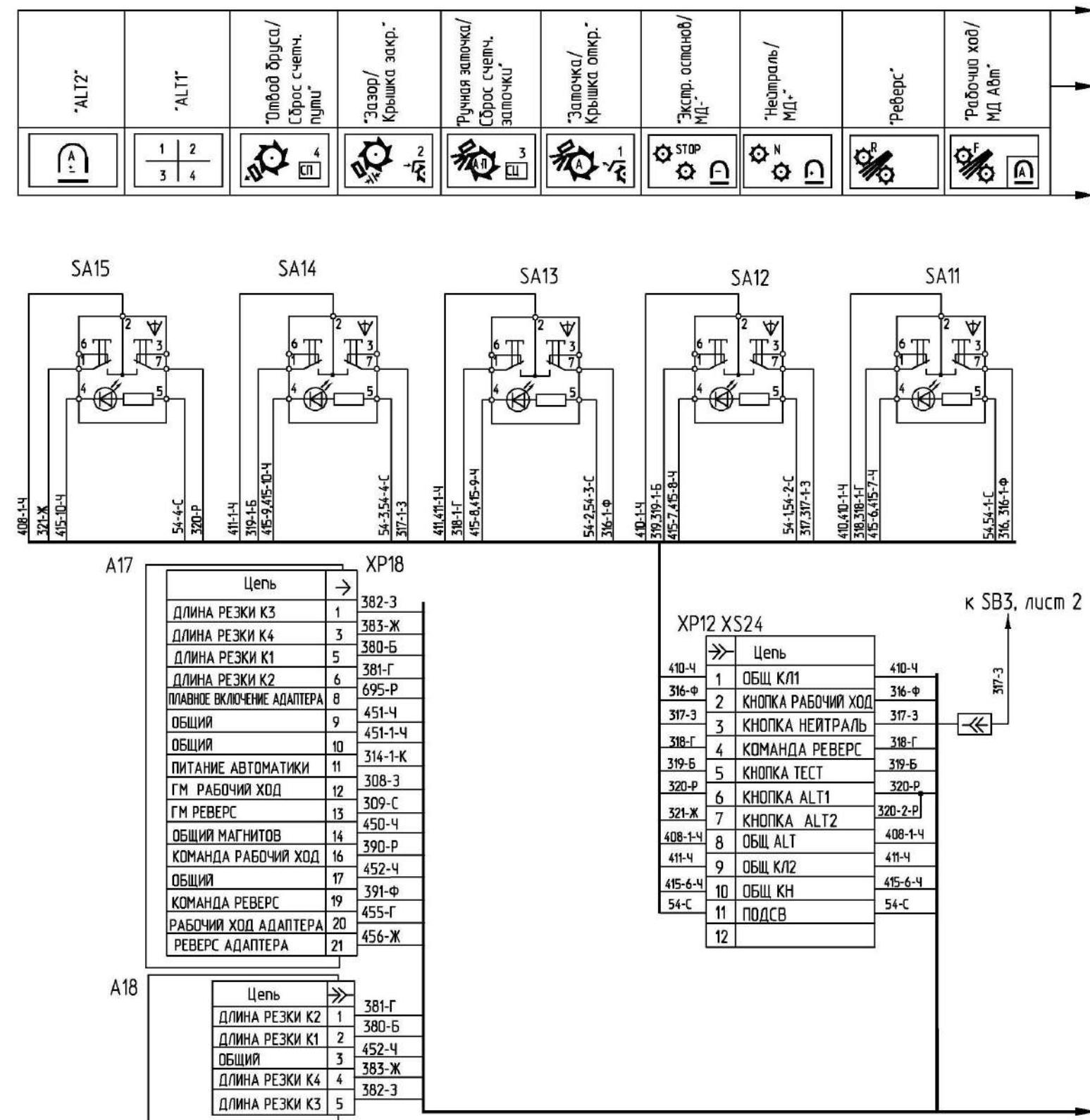
Рисунок Б.5 – Схема электрическая принципиальная комплекса (лист 1)
