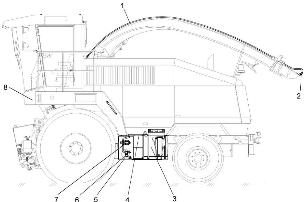
1 – электророжгут датчика наличия массы; 2 – датчик наличия массы; 3 – емкость для консерванта; 4 – площадка; 5 – рамка с ящиком для насоса; 6 – фильтр всасывающий; 7 – насос дозатор; 8 – измельчитель самоходный
