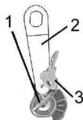
1 – замок зажигания; 2 – ключ специальный для открывания капотов; 3 – ключ зажигания
