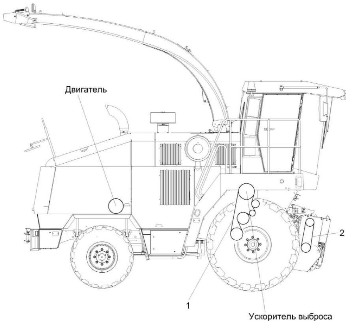
Рисунок Н.1 – Схема приводов измельчителя (вид справа)
