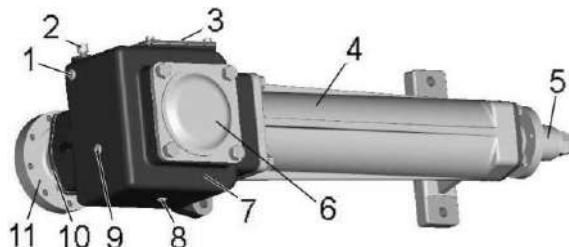
1 – пробка заливная; 2 – сапун; 3, 6, 10 – крышки; 4 – стакан; 5 – ступица приводного шкива; 7 – корпус; 8 – пробка сливная; 9 – пробка контрольная; 11 – ступица установки вентилятора
