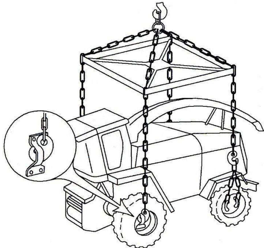
Рисунок 6.1 – Схема строповки
