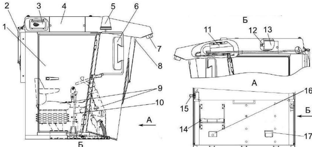
1 – дверь; 2 – задний стеклоочиститель; 3 – клапан; 4 – крышка; 5 – маяк проблесковый; 6 – зеркало; 7 – рабочие фары; 8 – передний стеклоочиститель; 9 – площадка управления; 10 – рычаг переключения передач; 11 – испаритель; 12 – прижим; 13 – фильтр; 14 – дополнительное сиденье; 15 – ручка дверная; 16 – аптечка; 17 – место для документации
