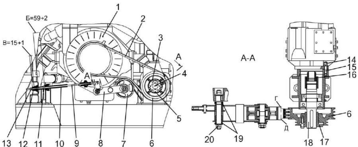
1, 6 – шкивы; 2 – ремень; 3 – болт; 4 – вал; 5 – пластина; 7 - ролик; 8 – рычаг; 9 – пружина; 11, 13, 14, 20 – гайки; 10 – винт; 12 – амортизатор; 15 – шпилька; 16 – полумуфта; 17 – ступица; 18 – вал; 19 – шайбы
