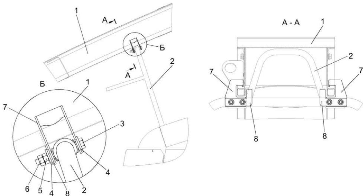
1 – силосопровод; 2 – стойка; 3 – болт; 4 – шайбы; 5 – гайки; 6 – контргайка; 7, 8 – кронштейны
