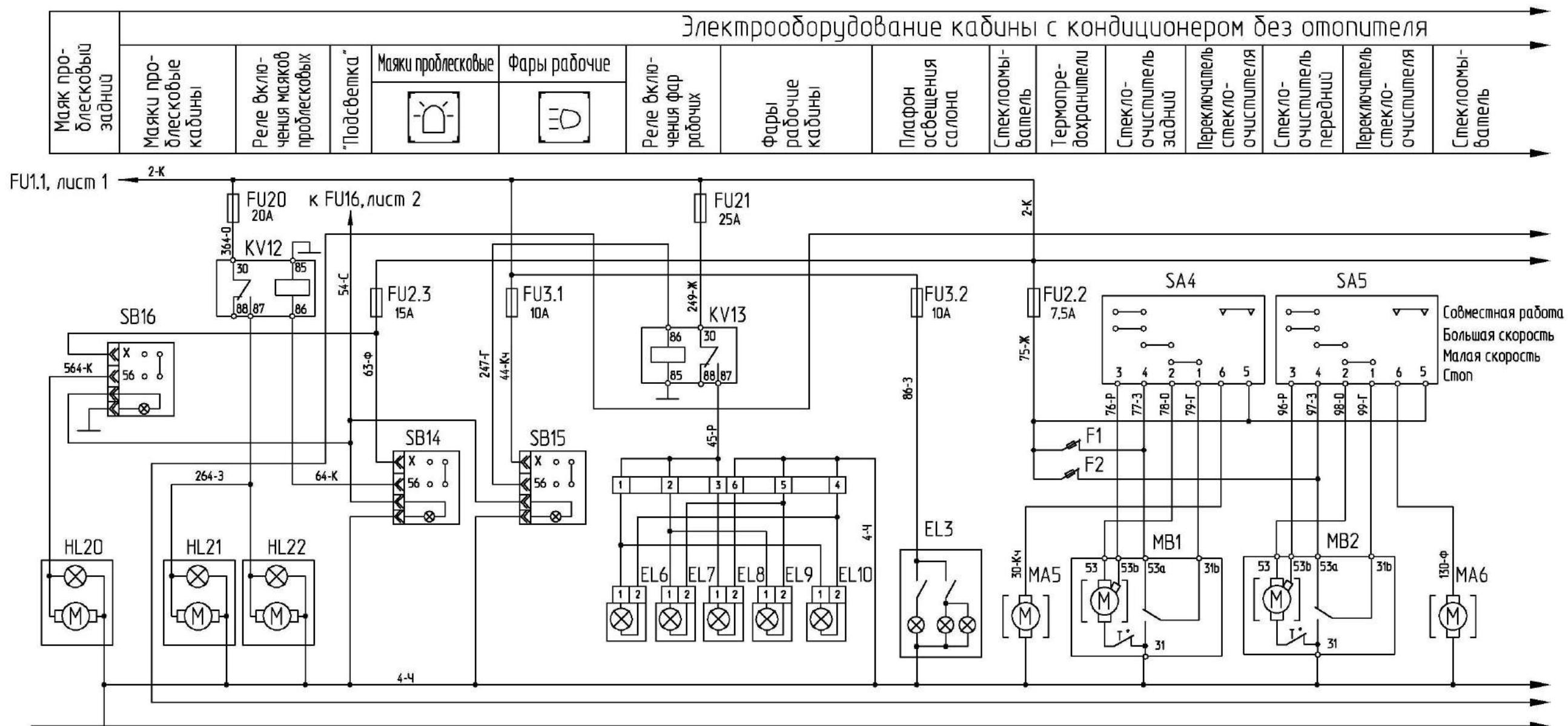
Рисунок Б.3 – Схема электрическая принципиальная комплекса (лист 1)
