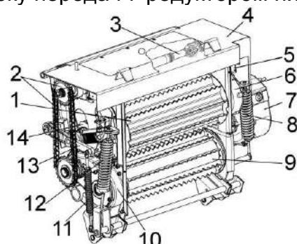
1 – валец верхний передний; 2 – передача цепная; 3 – вал карданный; 4 – корпус;
