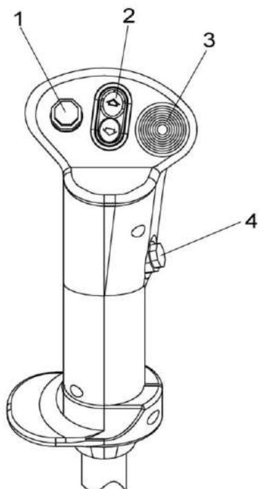
1 – кнопка экстренного останова питающего аппарата; 2 – переключатель управления навеской; 3 – кнопка управления силосопроводом; 4 – кнопка звукового сигнала
