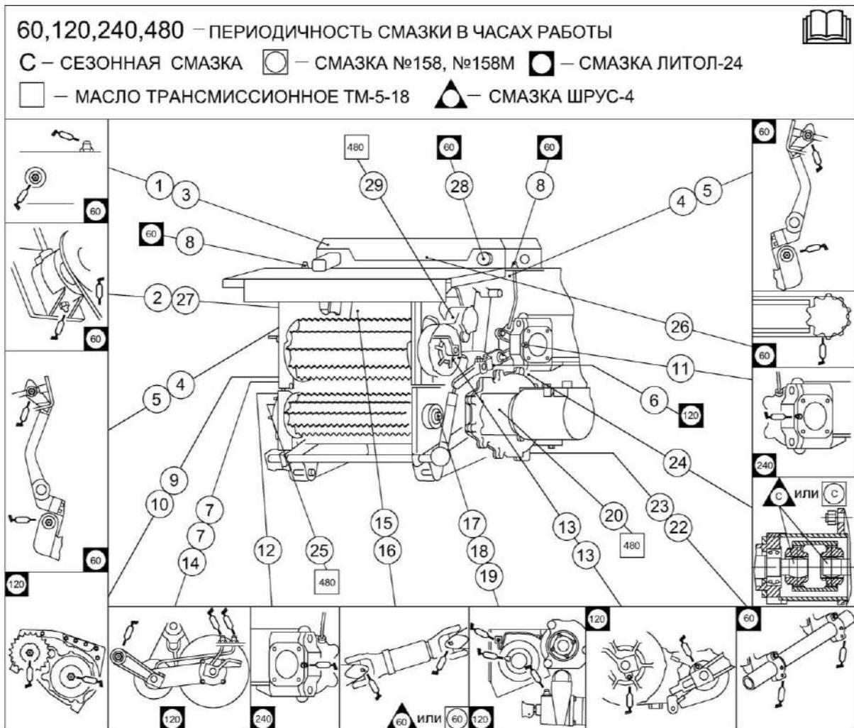
Рисунок 3.13 – Схема смазки питающе - измельчающего аппарата измельчителя
