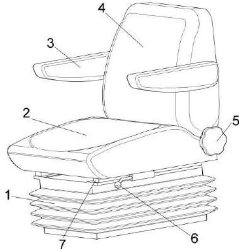
1 – чехол; 2 – подушка сиденья; 3 – подлокотник; 4 – спинка; 5 – рычаг фиксации наклона спинки; 6 - рычаг фиксации продольного перемещения; 7 - рукоятка регулировки сиденья по массе водителя
