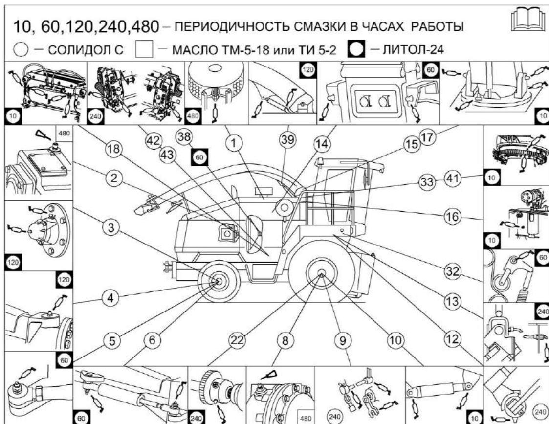
Рисунок 3.11 – Схема смазки измельчителя (вид справа)
