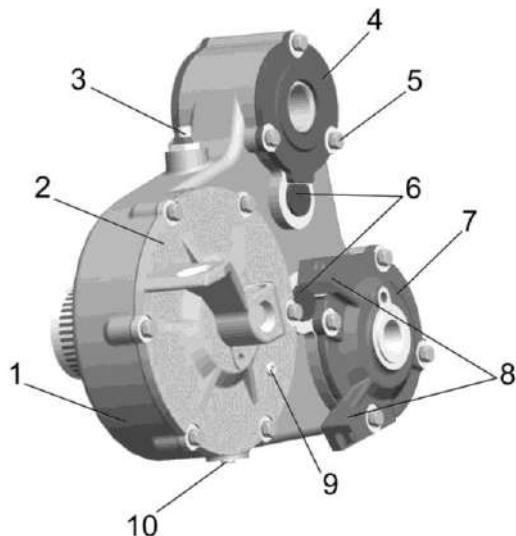
1 - корпус; 2, 4, 7 – крышки; 3 – сапун; 5 - болт; 6 - оси; 8 - ограничители угла поворота рычага верхних вальцов; 9 – пробка контрольная; 10 – пробка сливная
