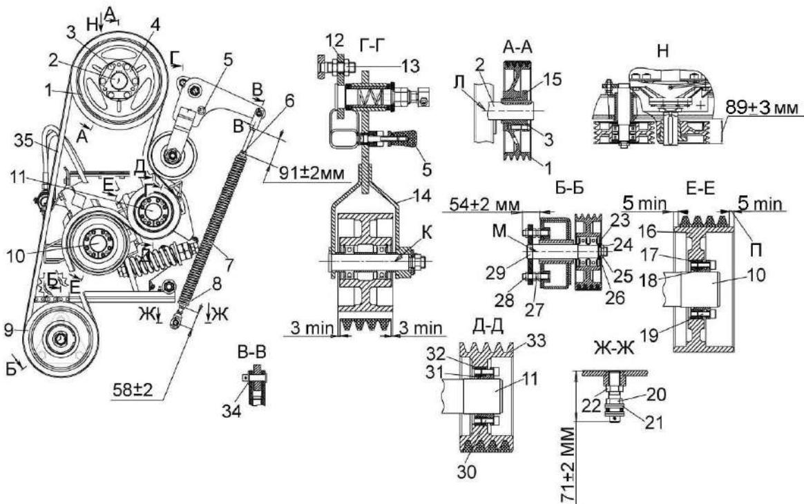
1, 33 – шкивы; 2 – вал ускорителя; 3 – болт; 4 - пластина; 5 – фиксатор; 6, 8, 13, 22, 28 – гайки; 7 – пружина; 9, 16 – ролики; 10 – вал вальца нижнего; 11 – вал вальца верхнего; 12, 29 – опоры; 14 - рычаг; 15, 18, 31 – ступицы; 17, 23, 32 - втулки; 19, 30 - винты; 20 - палец; 21, 26 – шайбы; 24 - гайка специальная; 25 – шайба специальная; 27 – шпилька; 34 – ось; 35 – ремень
