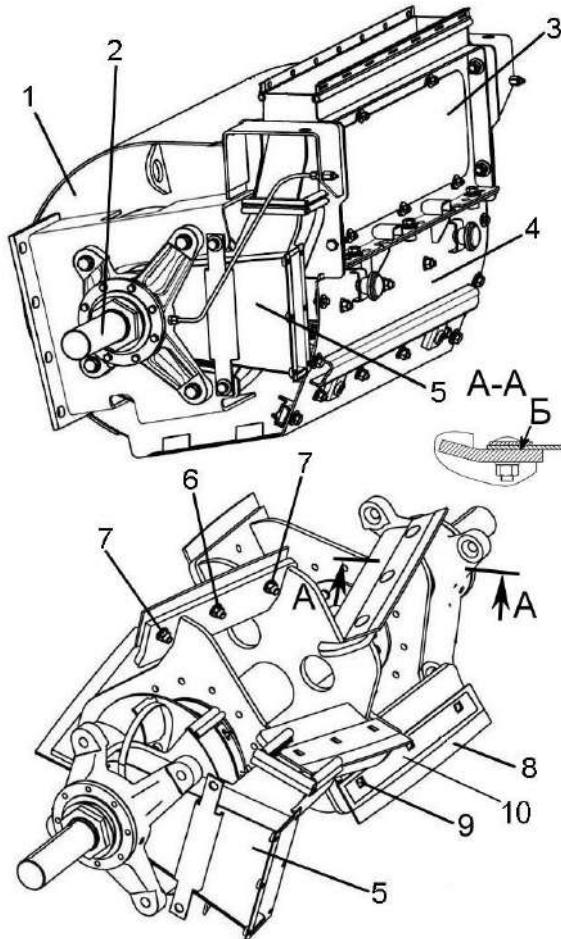
1 – корпус ускорителя; 2 – вал ускорителя; 3 – стенка задняя; 4 – поддон; 5 - воздуховод;
