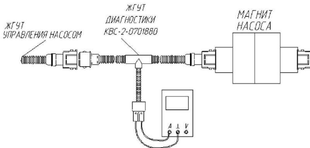
Рисунок М.3 - Подключение амперметра к магниту гидронасоса
