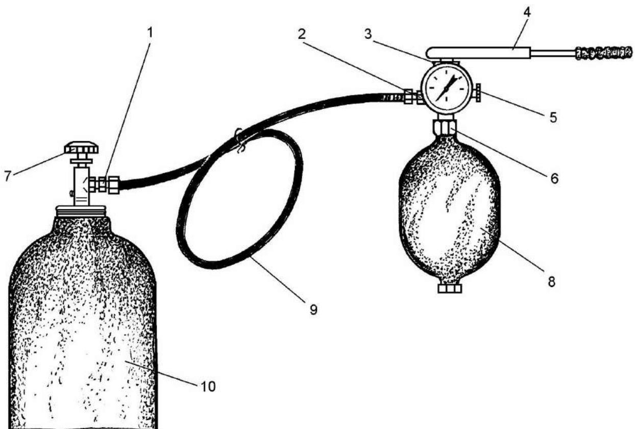
1 – переходник; 2 – обратный клапан зарядного устройства; 3 – зарядное устройство с манометром; 4 – динамометрический ключ с квадратной головкой  $\frac{1}{2}$ "; 5 – маховичик клапана для удаления газа; 6 – накидная гайка; 7 – маховичик запорного вентиля; 8 – пневмогидроаккумулятор; 9 – шланг; 10 – баллон с азотом
