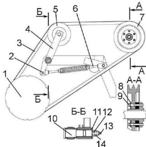
1, 7 – шкивы; 2, 10 – пальцы; 3 – ремень; 4 - рычаг; 5 – ролик натяжной; 6 - механизм натяжения; 8 – прокладки; 9 – болт; 11 – шайба; 12 – гайка; 13 – масленка; 14 – контргайка
