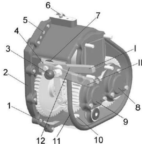
1 – болт; 2, 11 – корпуса; 3 – ручка шаровая; 4 - клеммовое соединение; 5 - штифт;
