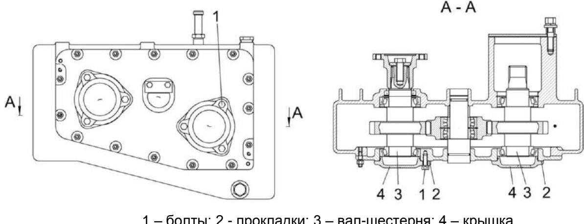
1 – болты; 2 - прокладки; 3 – вал-шестерня; 4 – крышка
