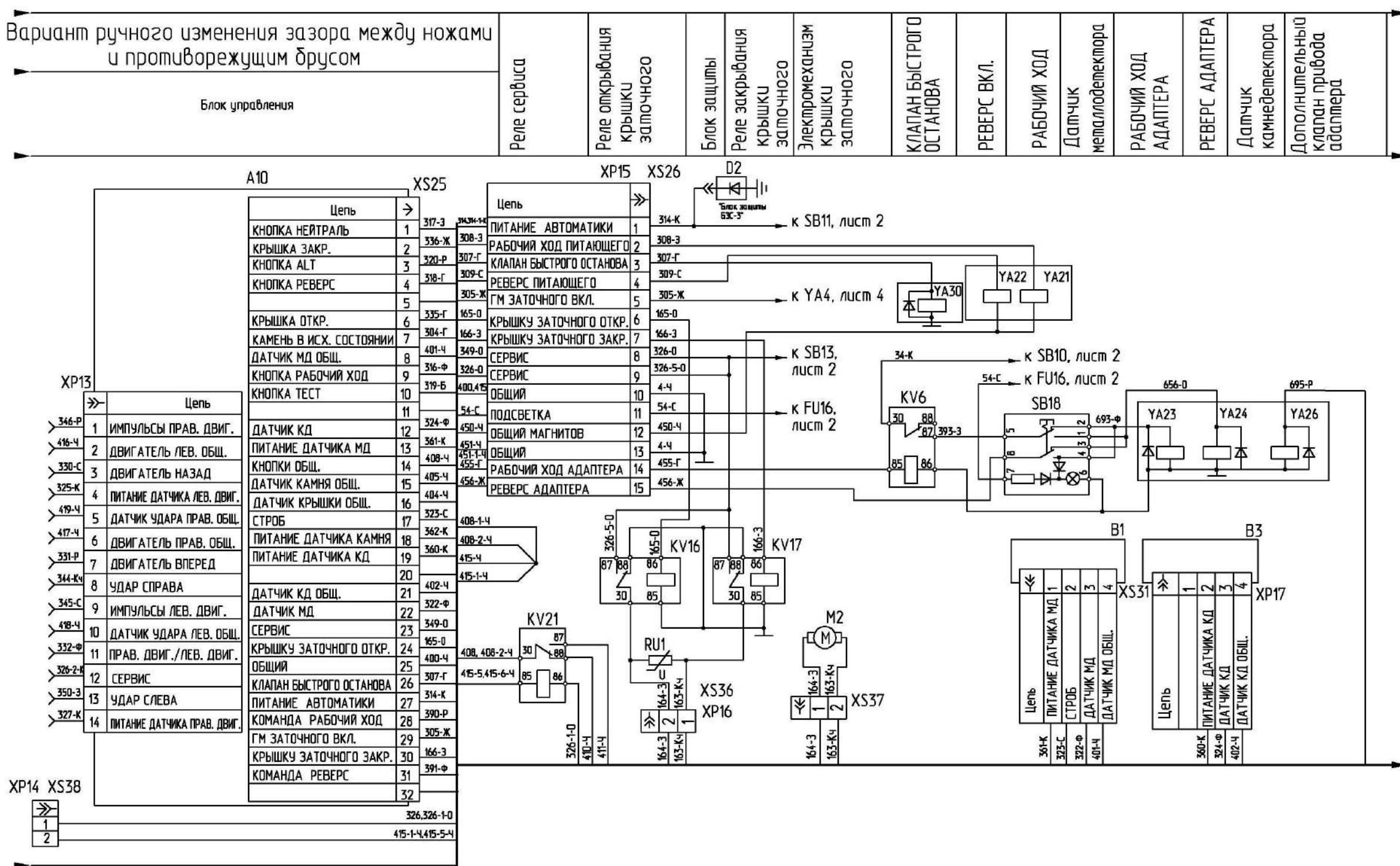
Рисунок Б.5 – Схема электрическая принципиальная комплекса (лист 2)
