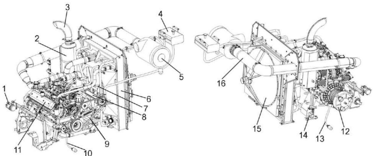
1 – компрессор кондиционера; 2 – глушитель; 3 - труба выхлопная; 4 – бачок расширительный; 5 – воздухоочиститель; 6 - блок радиаторов; 7 – вентилятор; 8 - редуктор привода вентилятора; 14 - опоры двигателя; 10 – рукав слива охлаждающей жидкости; 11 – двигатель; 12 – главный привод; 13 – рукав слива масла из поддона двигателя; 15 – воздухозаборник; 16 - труба воздушная
