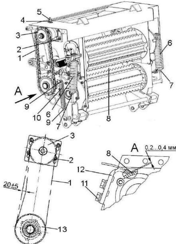
1 – цепь; 2, 4 – гайки; 3,13 – звездочки; 5, 7, 9 – контргайки; 6, 10 – пружины; 8 – валец гладкий; 11 – болт; 12 – чистик
