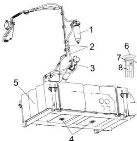
1 – фильтр; 2 – топливопроводы; 3 - заливная горловина; 4 – клапан сливной; 5 – бак; 6 – крышка; 7 – пружина; 8 - сетка
