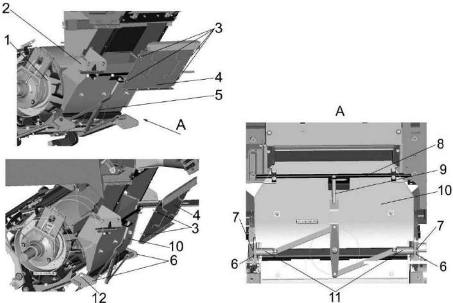
1 – барабан измельчающий; 2 – простоявка; 3 – фиксаторы быстросъемные; 4 – стенка съемная; 5 – механизм открытия приемной камеры; 6 – направляющие; 7 – фиксаторы; 8 – ось; 9 – рычаг; 10 – приемная камера; 11 – втулки; 12 – отверстия для фиксации
