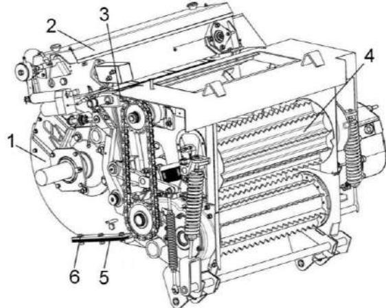
1 – аппарат измельчающий; 2 – заточное устройство; 3 - скоба; 4 – аппарат питающий;
