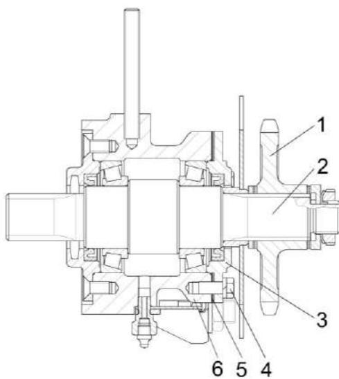
1 – звездочка; 2 - вал; 3 – крышка; 4 – болты; 5 – прокладки; 6 – корпус
