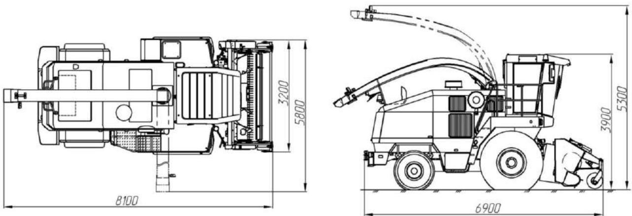
Рисунок 1.1 – Габаритные размеры комплекса с подборщиком
