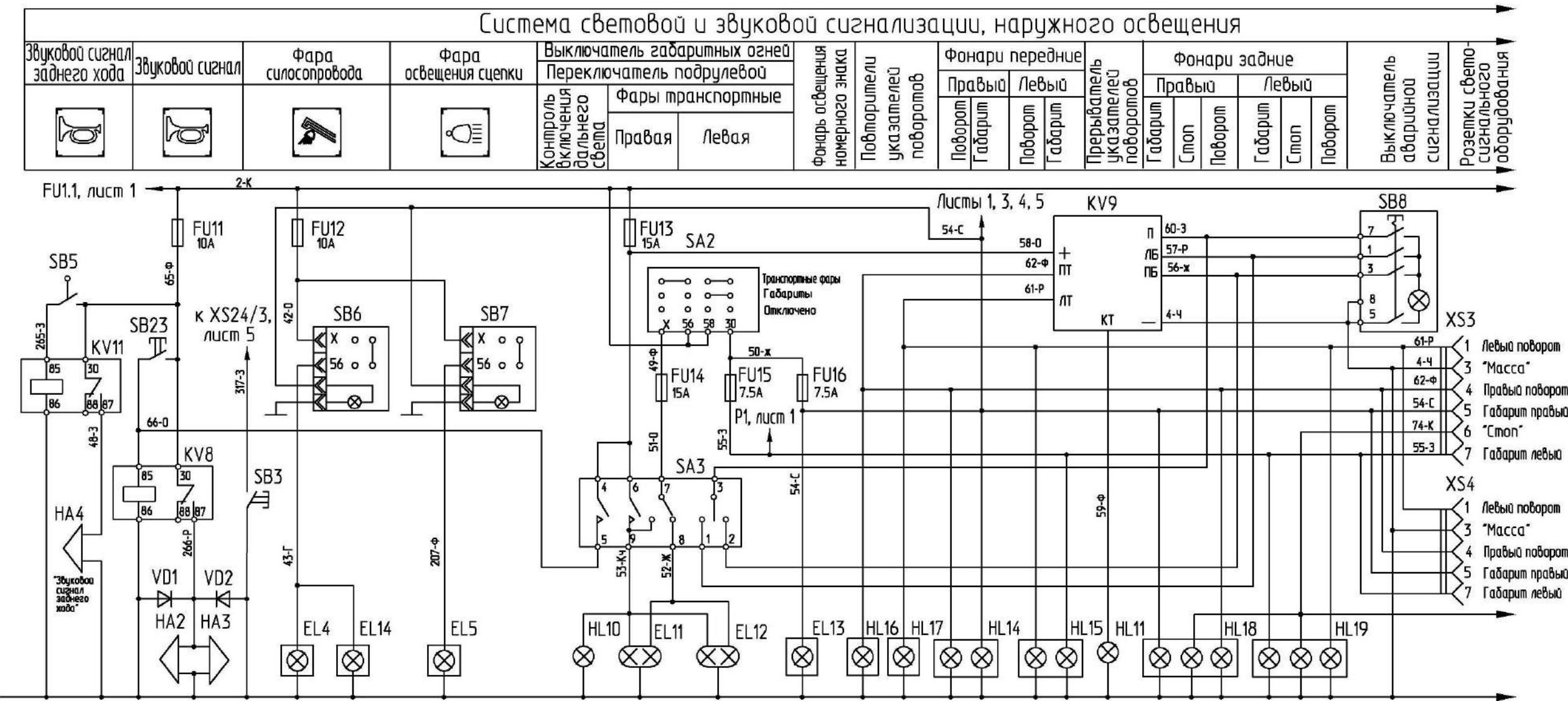
Рисунок Б.2 - Схема электрическая принципиальная комплекса (лист 1)
