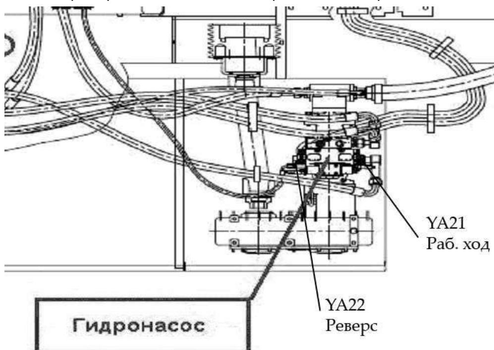
Рисунок М.2 - Расположение магнитов гидронасоса
