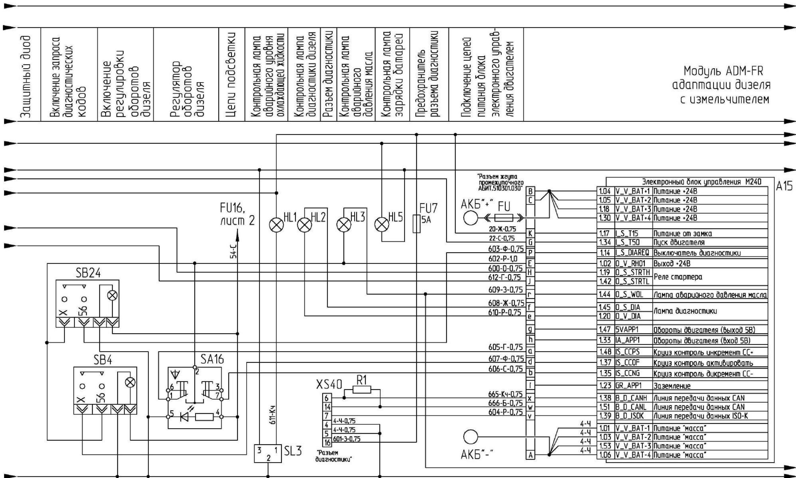
Рисунок Б.1 – Схема электрическая принципиальная комплекса (лист 2)
