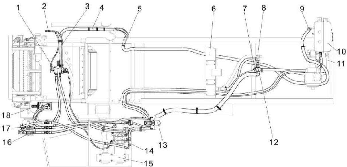
1 – гидроблок адаптеров; 2 – точки диагностики; 3, 4, 11 – рукава; 5, 7, 9 – хомуты; 6 – радиатор масляный; 8 – коллектор; 10 - бак масляный; 12 – клапан обратный; 13 – фильтр напорный; 14 – гидронасос двухсекционный; 15 – редуктор привода гидронасосов; 16 – гидромотор привода питающего аппарата с гидроблоком экстренного останова; 17 - полумуфта заправочная; 18 – гидромотор привода режущего аппарата
