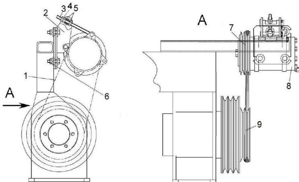
1 – ременная передача; 2 – кронштейн; 3 – тяга; 4 – контргайка; 5, 6 – гайки; 7, 9 – шкивы; 8 – компрессор
