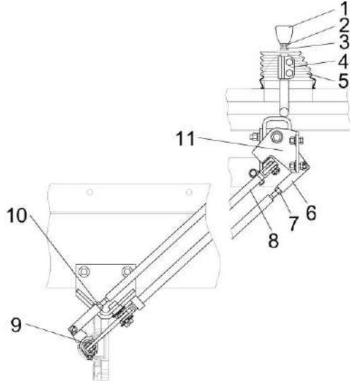
1 – рукоятка; 2 – гайка; 3 – рычаг; 4 – муфта; 5 – чехол; 6, 8 – тяги; 7, 10 – контргайки; 9 – шток; 11 - блок переключения
