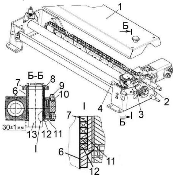
1 – крышка; 2 – каретка; 3 – прижим; 4 – фиксатор; 6 – втулка резьбовая; 7 - втулка; 8 – колесо храповое; 9 – устройство стопорное; 10 – планка; 11 – кольцо; 12 – кольца резиновые (4 шт); 13 – бруск абразивный
