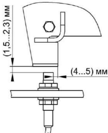
Рисунок 2.12 – Установка датчика положения бруска абразивного
