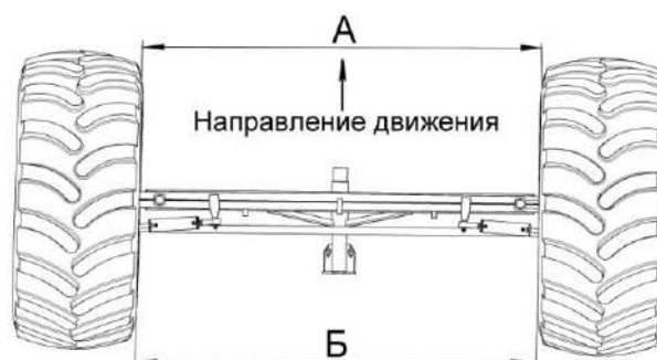
Рисунок 2.26 - Регулировка сходимости колес
