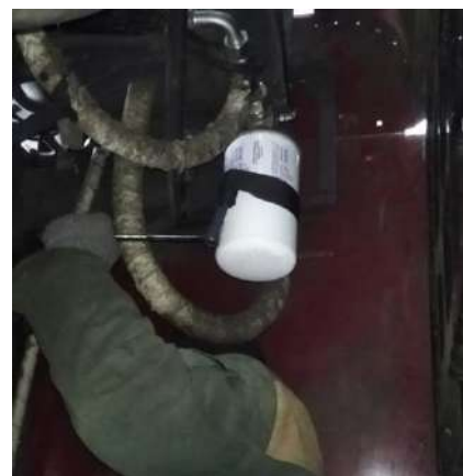
Рисунок 3.10 – Сливной фильтроэлемент, демонтируемый при помощи ключа фильтра
