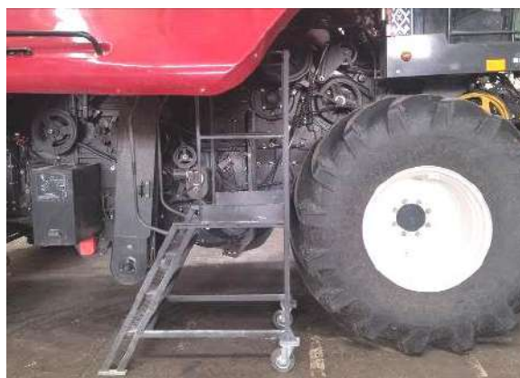
Рисунок 3.3 – Лестница с площадкой для заправки насоса АЦСС
