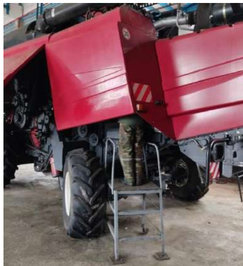
Рисунок 3.8 – Вид на лестничную площадку с оператором при замене сливного и напорного фильтроэлементов
