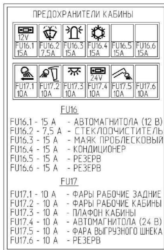
Рисунок 1.42 – Схема расположения предохранителей
