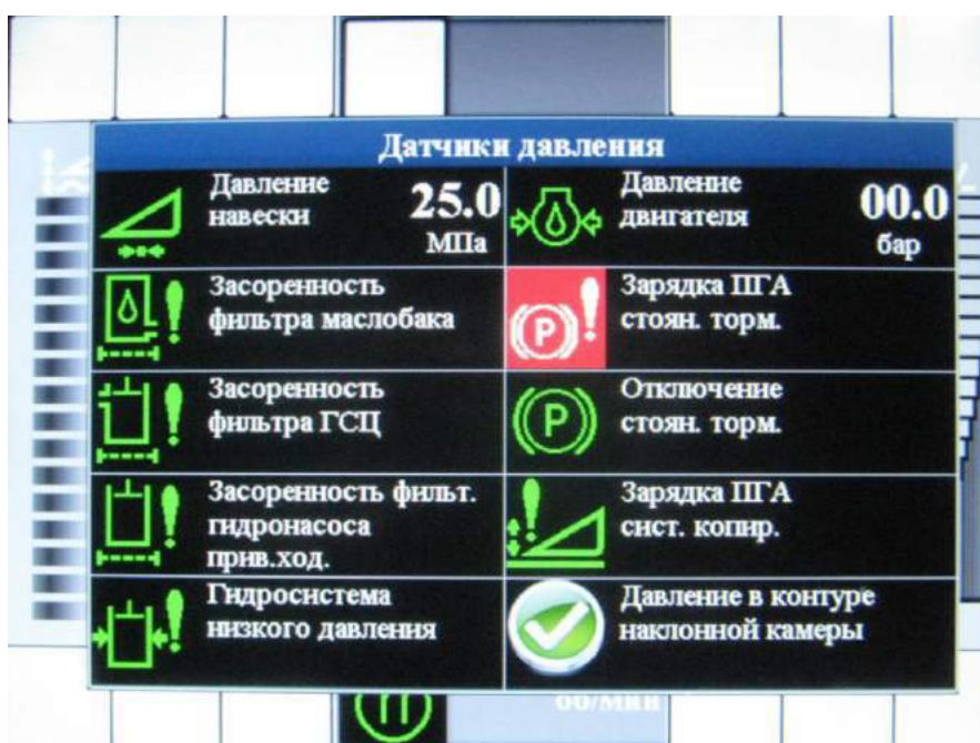
Рисунок Ж. 10 – Вид окна «Датчики давления»
