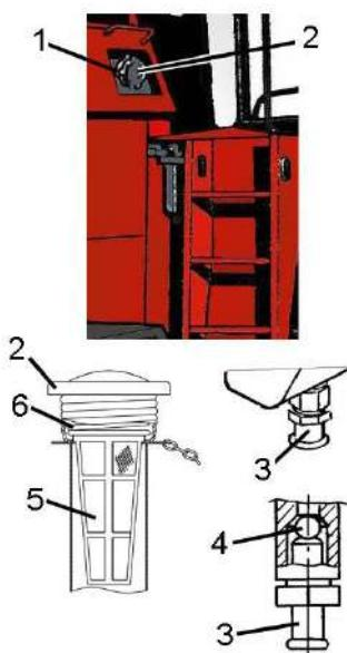
1 – заливная горловина; 2 – крышка; 3 – сливной штуцер; 4 – шарик; 5 – сетка; 6 – пружина
