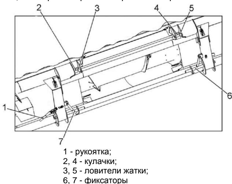
Рисунок 2.12 - Навеска жатки на наклонную камеру
