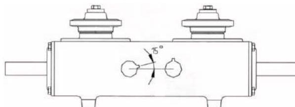
Рисунок 2.21 – Установка положения шпонок на валах привода вальцов жатки
