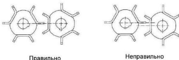
Рисунок 2.17 – Положение осей вальцов в вертикальной плоскости
