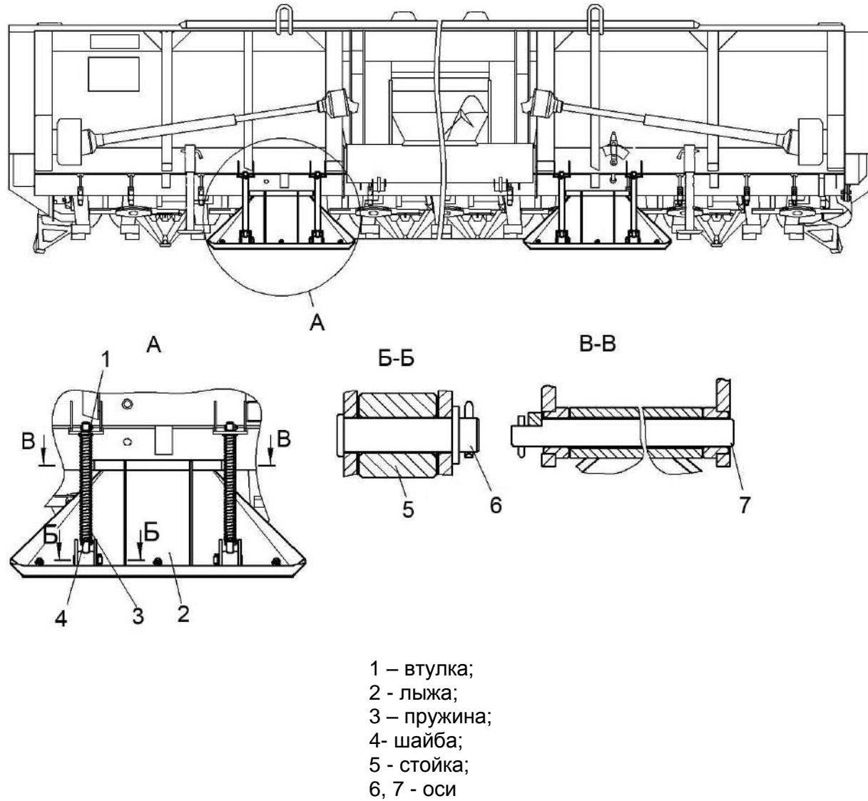
Рисунок 1.5 – Установка приспособления для загиба стерни
