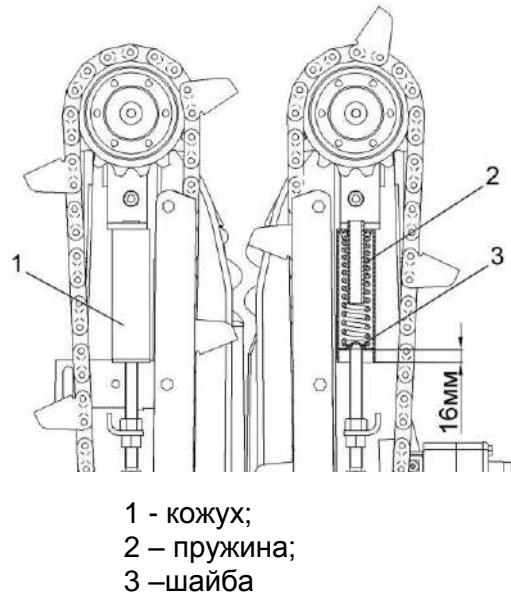
Рисунок 2.20 – Регулировка натяжения подающей цепи
