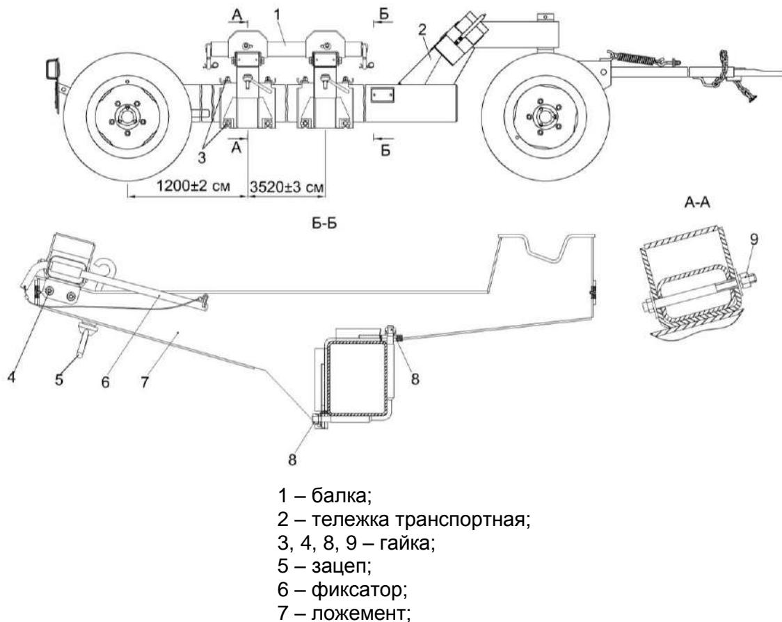
Рисунок 2.1 – Переоборудование транспортной тележки
