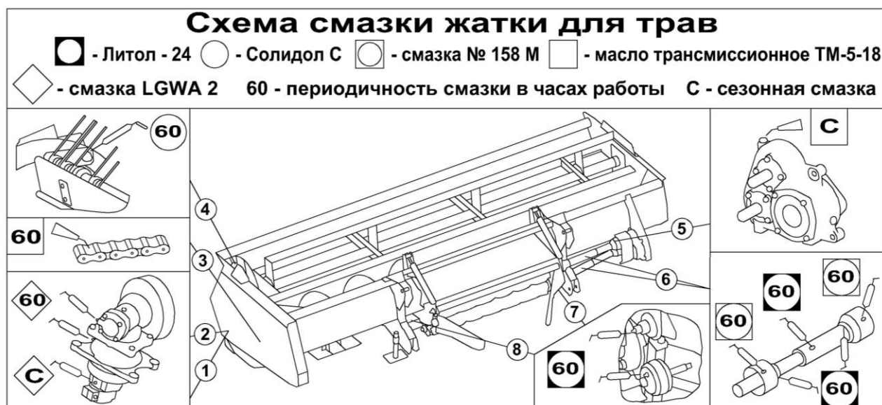
Рисунок 3.2 – Схема смазки жатки
