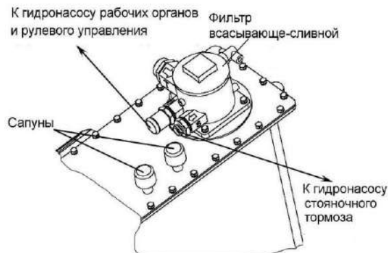
Рисунок 3.13 – Замена фильтроэлемента фильтра и сапунов
