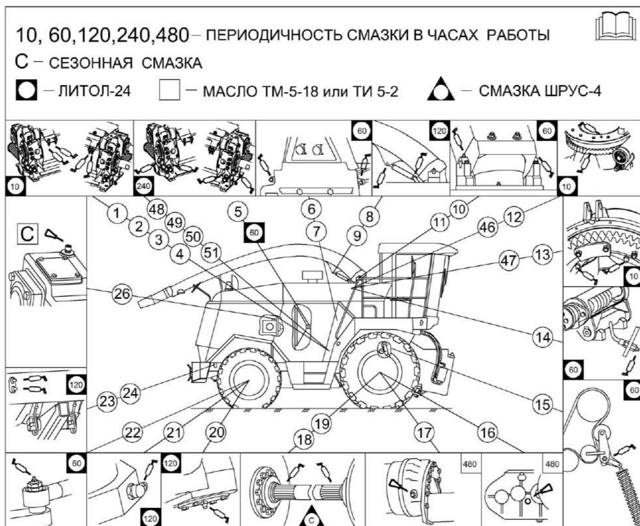
Рисунок 3.14 – Схема смазки измельчителя КВК 0100000 (вид справа)
