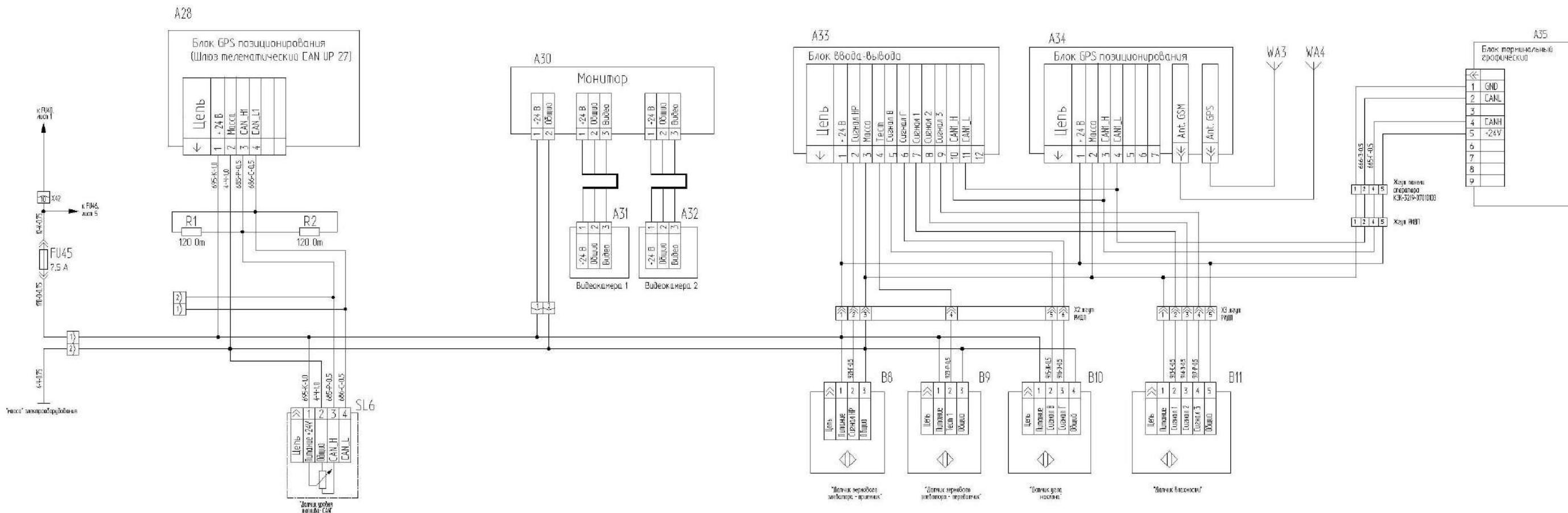
Рисунок Б.9 – Схема электрическая принципиальная комбайна (лист 9)
