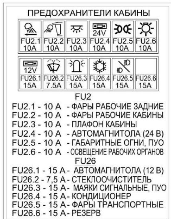
Рисунок 1.38 – Схема расположения предохранителей
