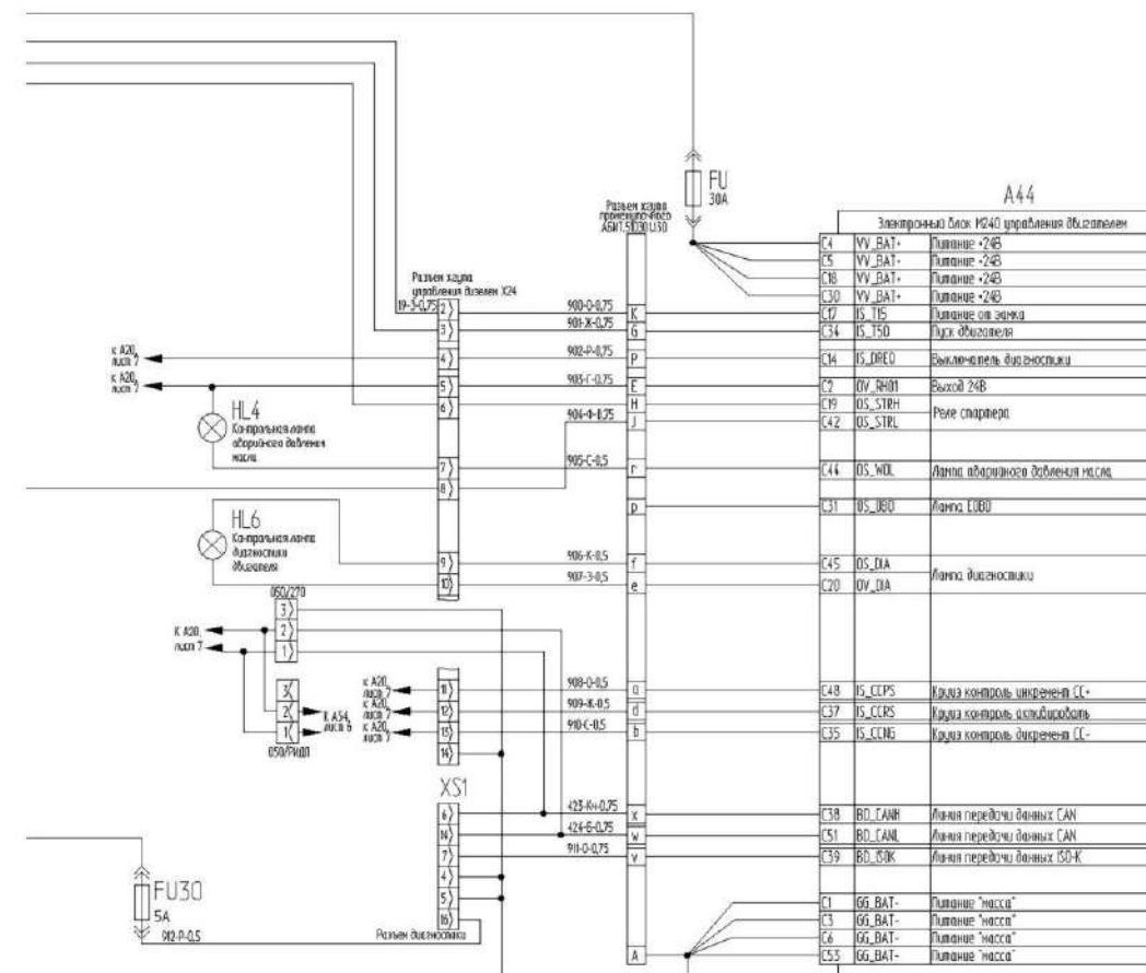
Рисунок Б.1 – Схема электрическая принципиальная комбайна (лист 1)
