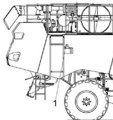
1 – крышка заливной горловины топливного бака
