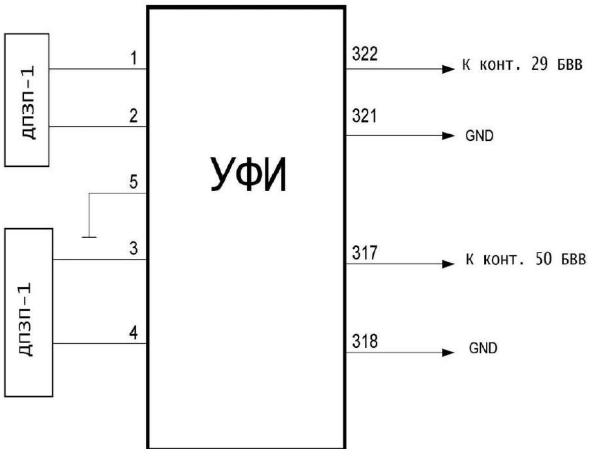
ДПЗП-1 – датчик потерь зерна пьезоэлектрический
