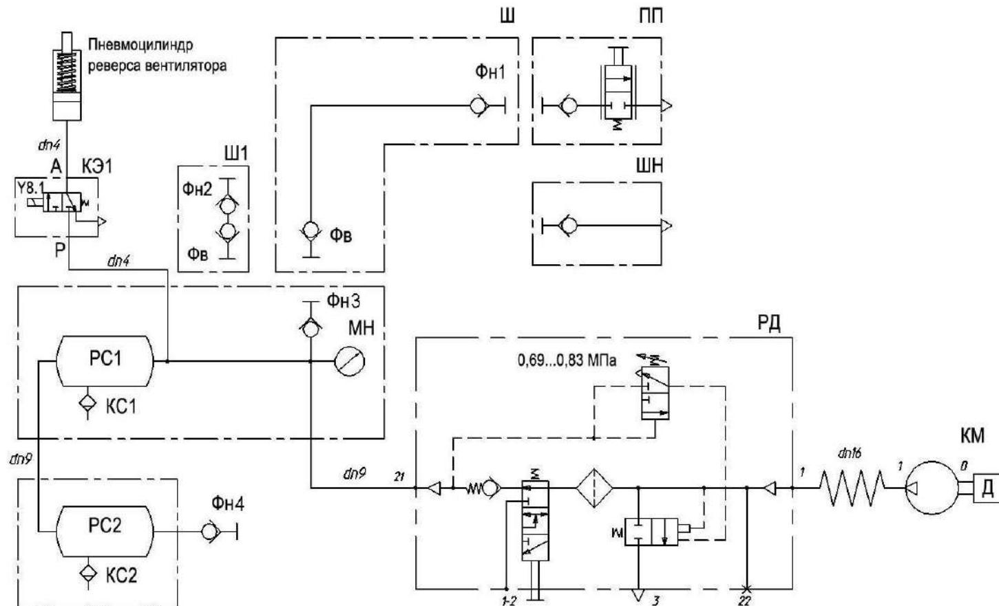
КМ - компрессор; КС1, КС2 – клапан слива конденсата; КЭ1 – клапан электромагнитный; МН – манометр; ПП – пневмопистолет обдувочный; РД – регулятор давления; РС1, РС2 – ресиверы; Фв – фитинг; Фн1, Фн2 – фитинг; Фн3, Фн4 – фитинг; Ш – шланг; Ш1 – шланг; ШН – шланг для накачивания шин
