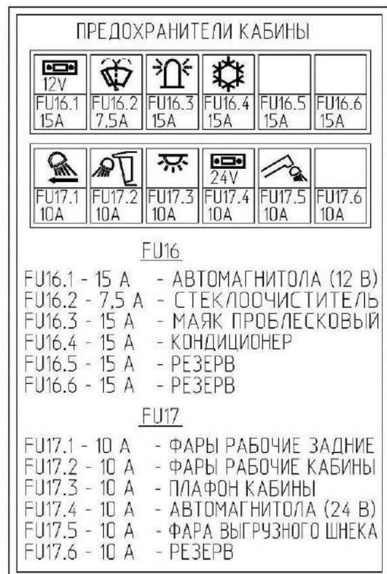
Рисунок 1.44 – Схема расположения предохранителей
