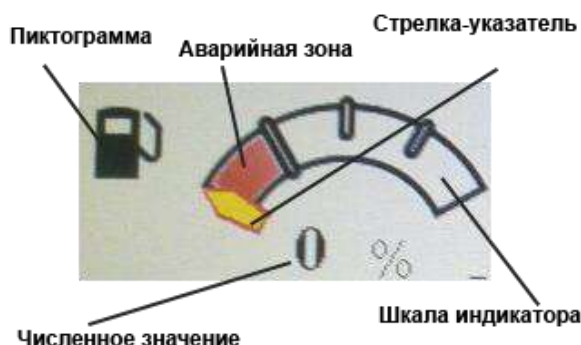
Рисунок Н.3– Пример стрелочного индикатора
