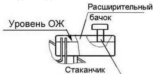
Рисунок 3.3 – Контроль уровня охлаждающей жидкости
