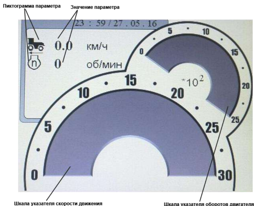
Рисунок Н.5 – Индикатор приборной панели
