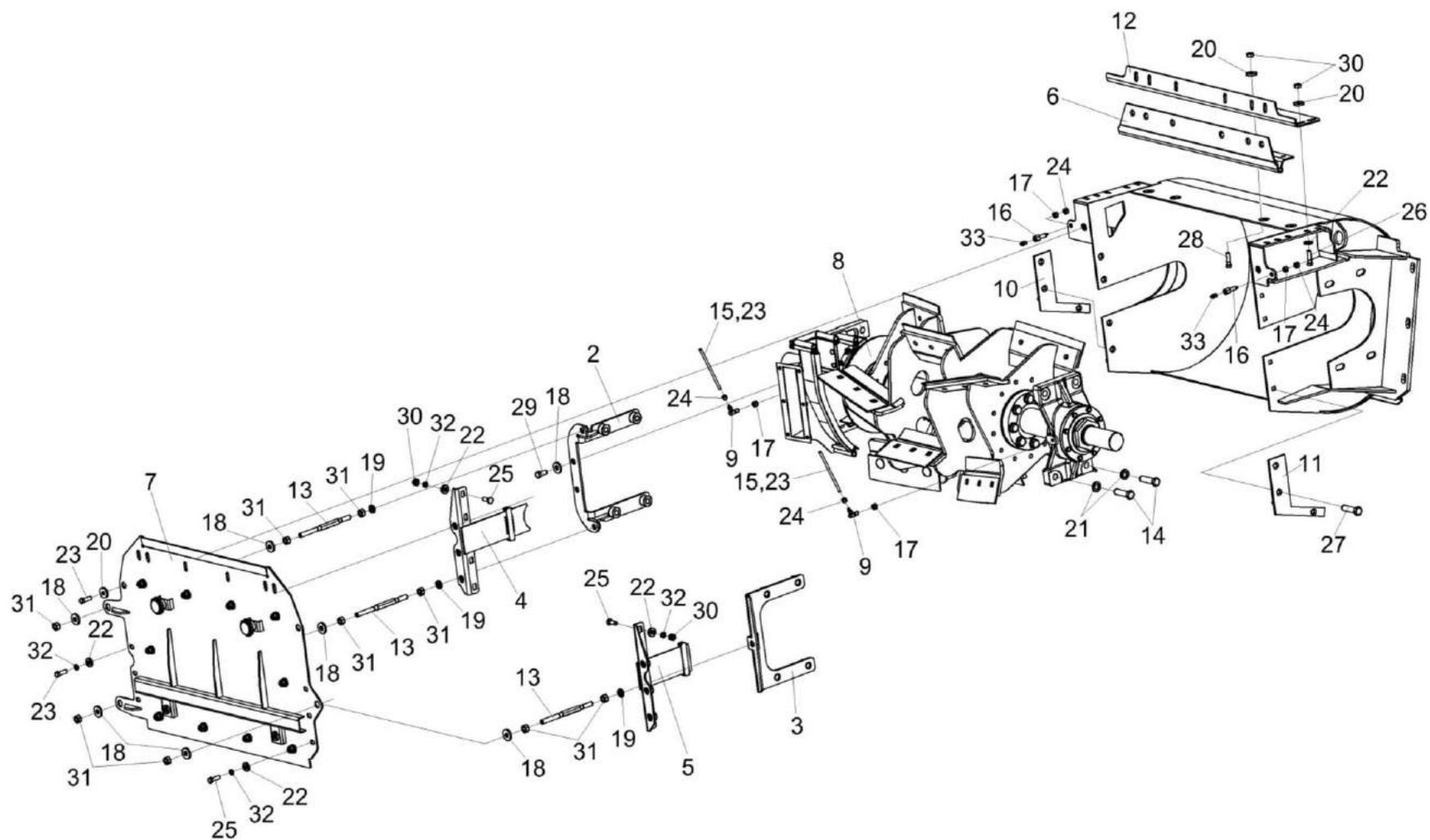
Рисунок 55 – Ускоритель выброса КВК-6-0142000
