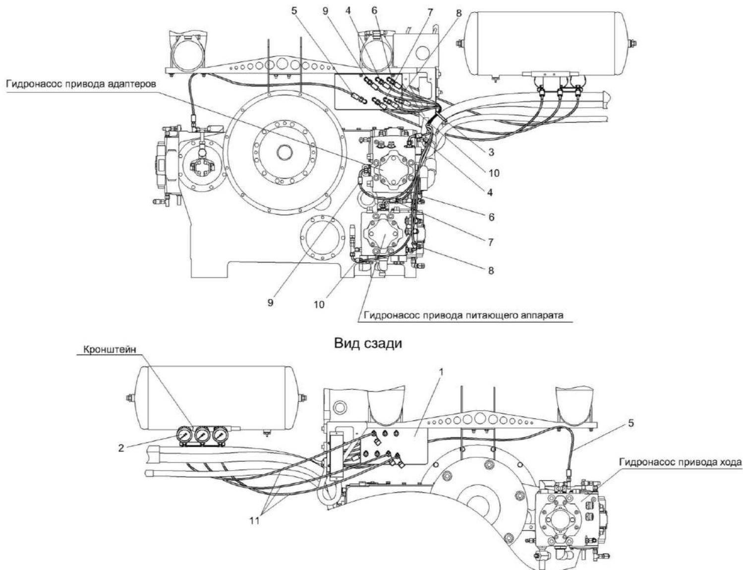
Рисунок 205 – Установка панели диагностики КВК-6-0604500
