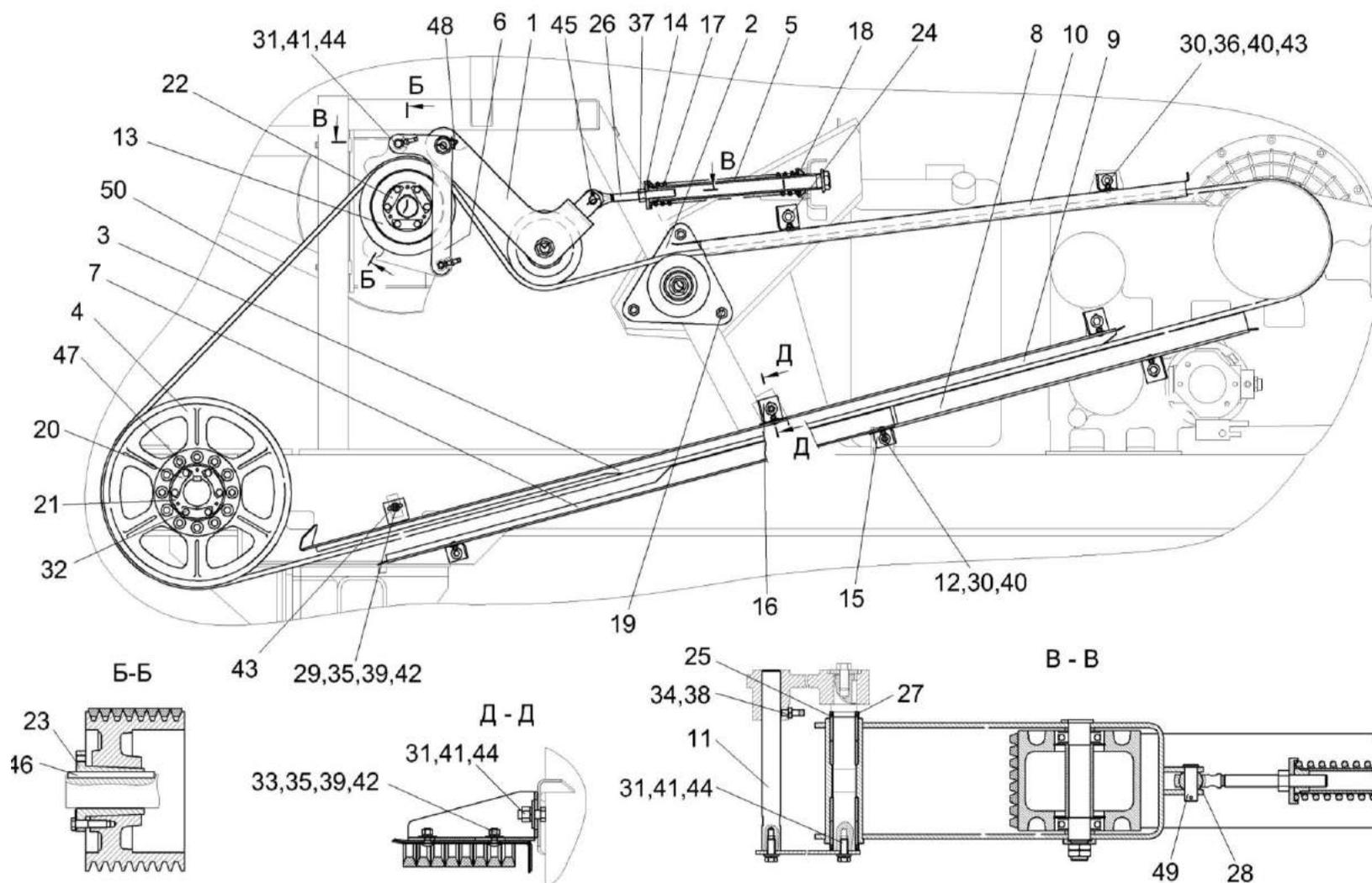
Рисунок 40 – Привод измельчающего барабана КВК-6-0130000
