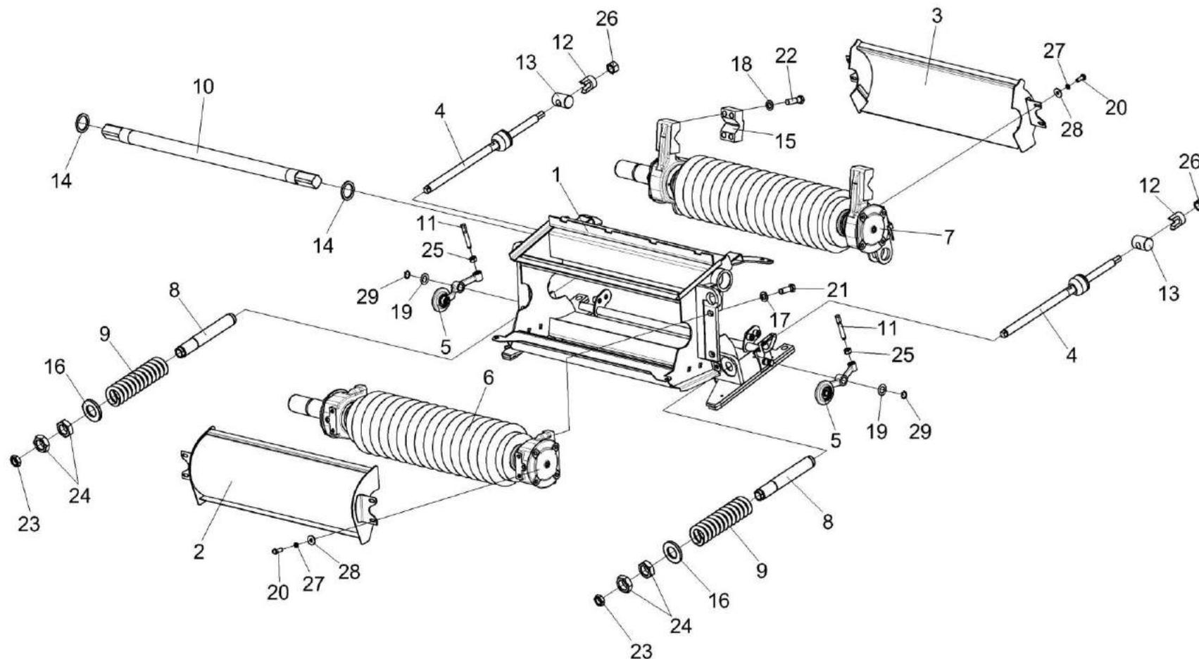
Рисунок 47 – Устройство доизмельчающее КВК 0149010 (лист 1)
