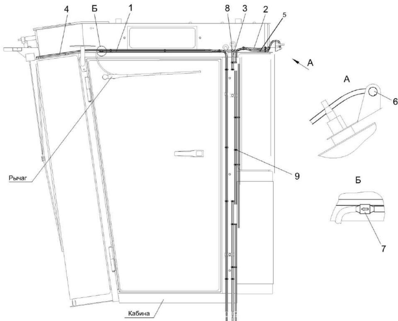
Рисунок 137 – Установка трубопроводов стеклоомывателя КВК 0120650
