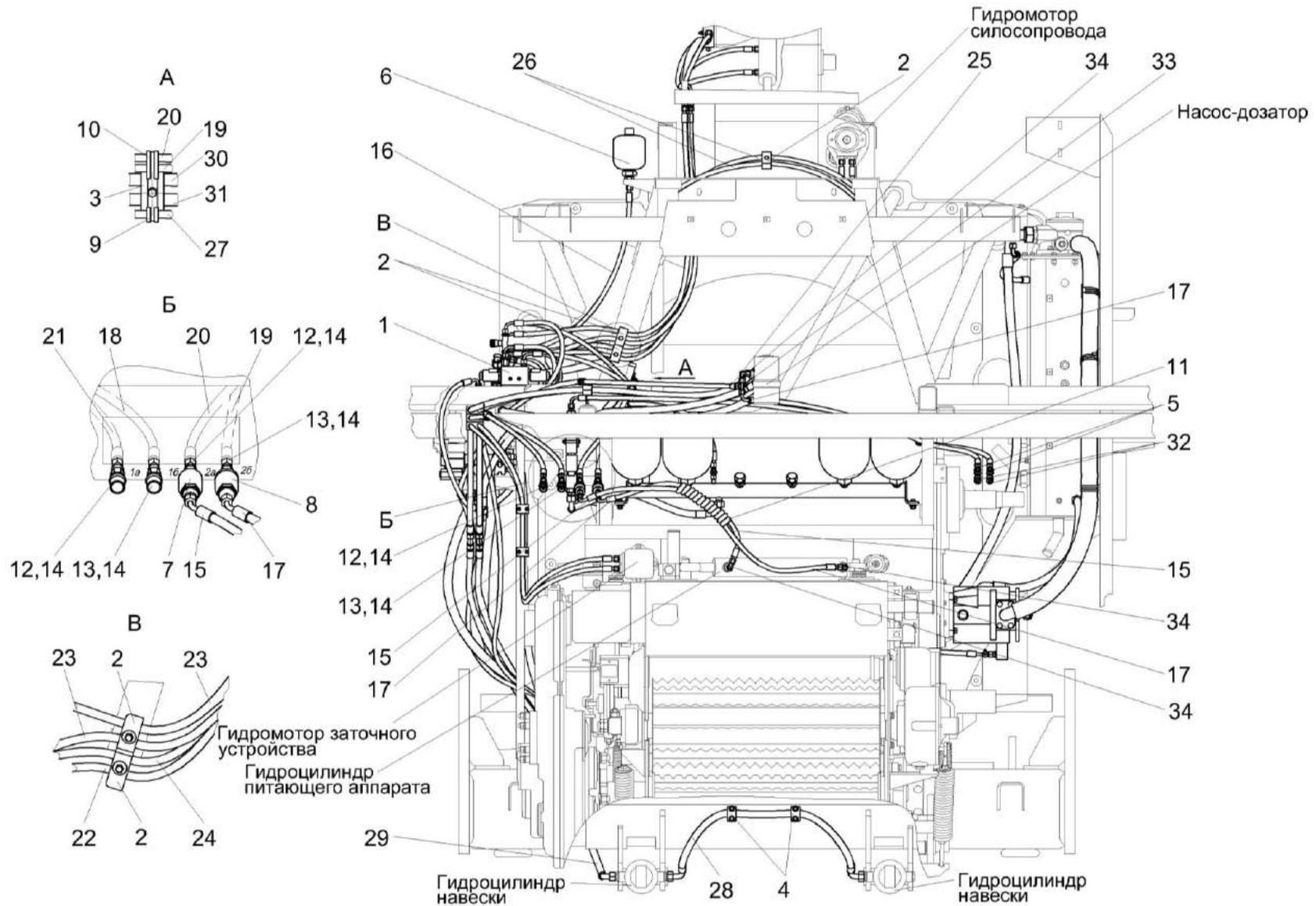
Рисунок 184 – Гидросистема рулевого управления и силовых гидроцилиндров КВК-6-0602000 (лист 1)
