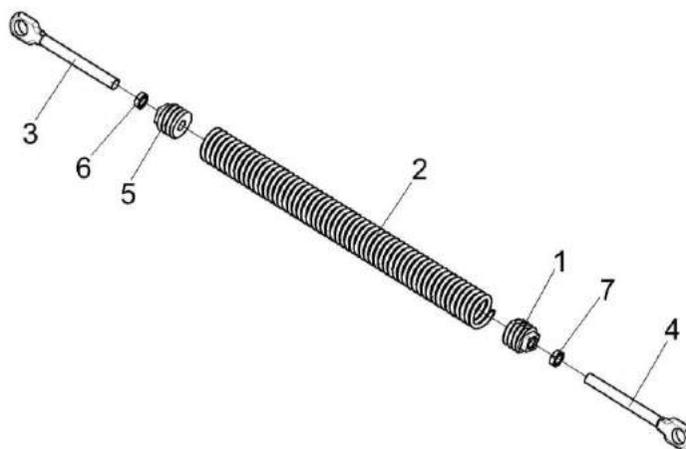
Рисунок 90 – Пружина КВС-1-0155260
