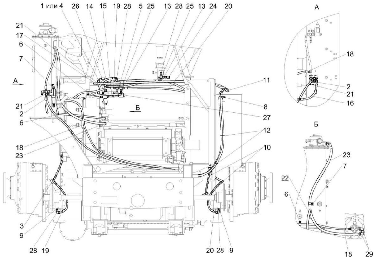
Рисунок 215 – Гидросистема привода стояночного и динамического тормозов КВК-6-0606000 (лист 2)
