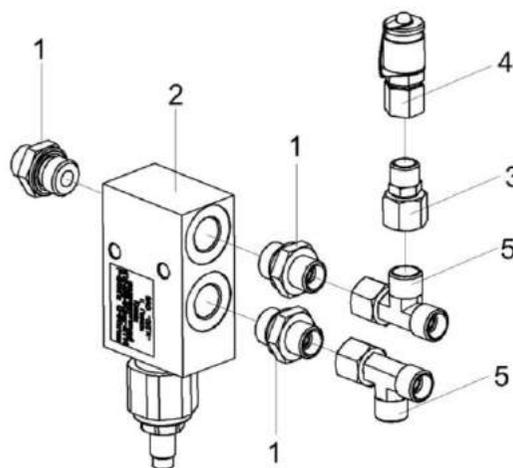
Рисунок 194 – Клапан предохранительный КВК-6-0602400
