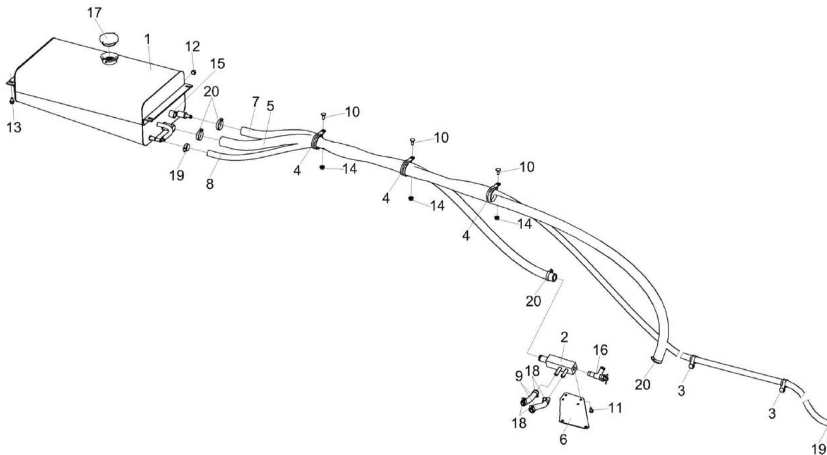
Рисунок 94 – Установка бачка расширительного КВК-6-0154000
