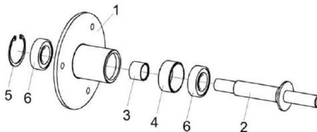
Рисунок 88 – Корпус КВК-6-0155110
