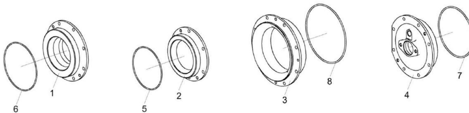
Рисунок 76 – Стаканы КВК-6-0137010, КВК-6-0137020, КВК-6-0137030, КВК-6-0137040
