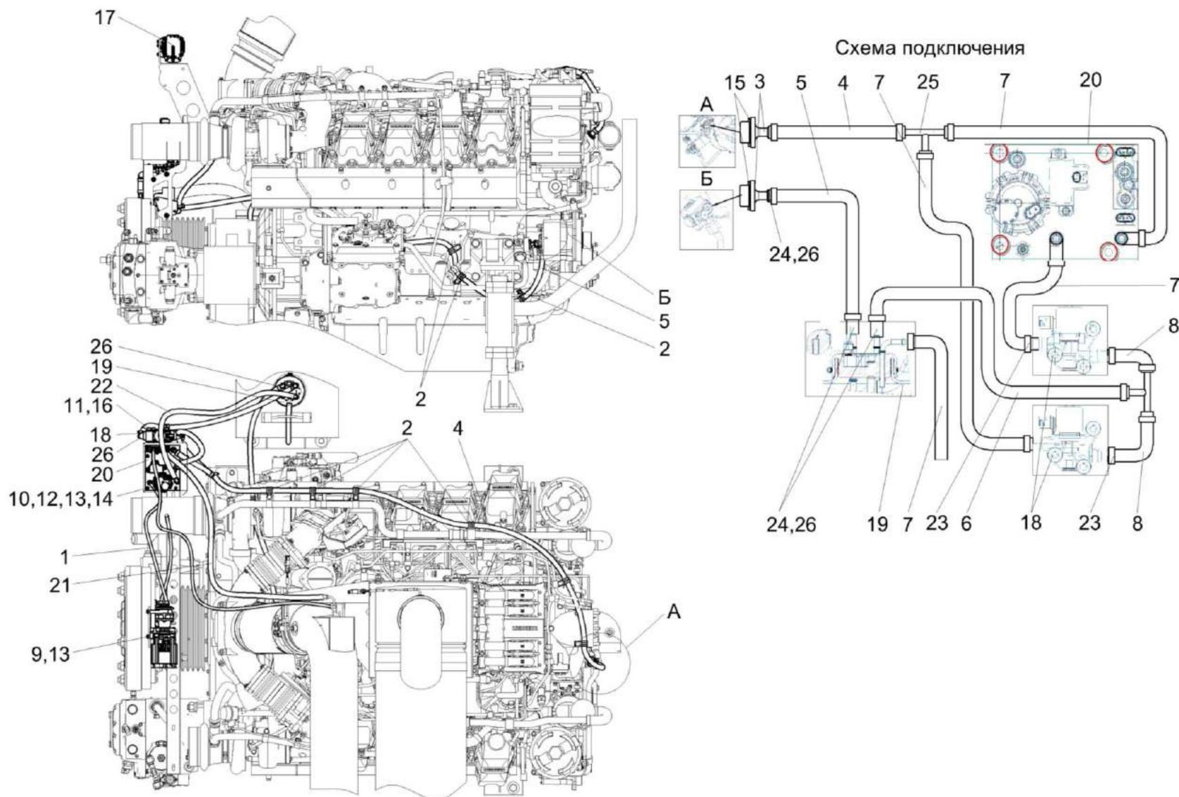
Рисунок 72 – Установка дополнительного оборудования КВК-6-0150900
