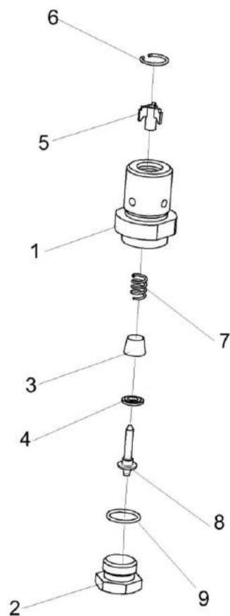
Рисунок 104 – Клапан сливной КВС-1-0103180
