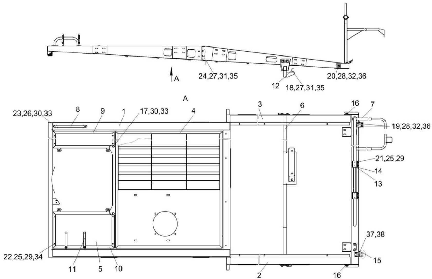
Рисунок 166 – Крыша КВК-6-0162000
