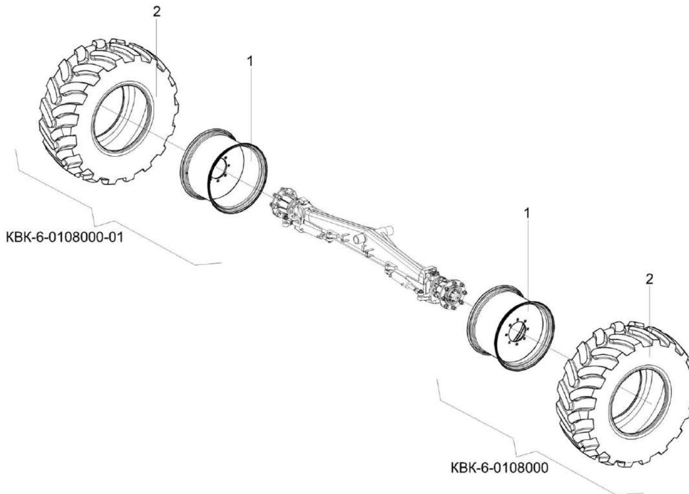
Рисунок 123 – Колеса КВК-6-0108000 и КВК-6-0108000-01
