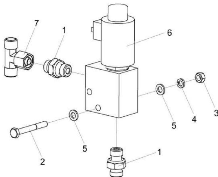
Рисунок 189 – Клапан козырька силосопровода КВК-6-0602390 и КВК-6-0602390-01
