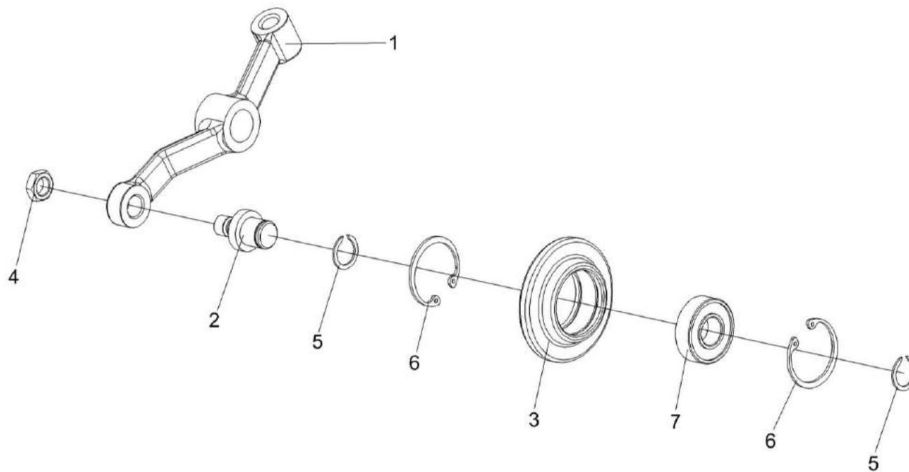
Рисунок 49 – Рычаг КВК 0149150
