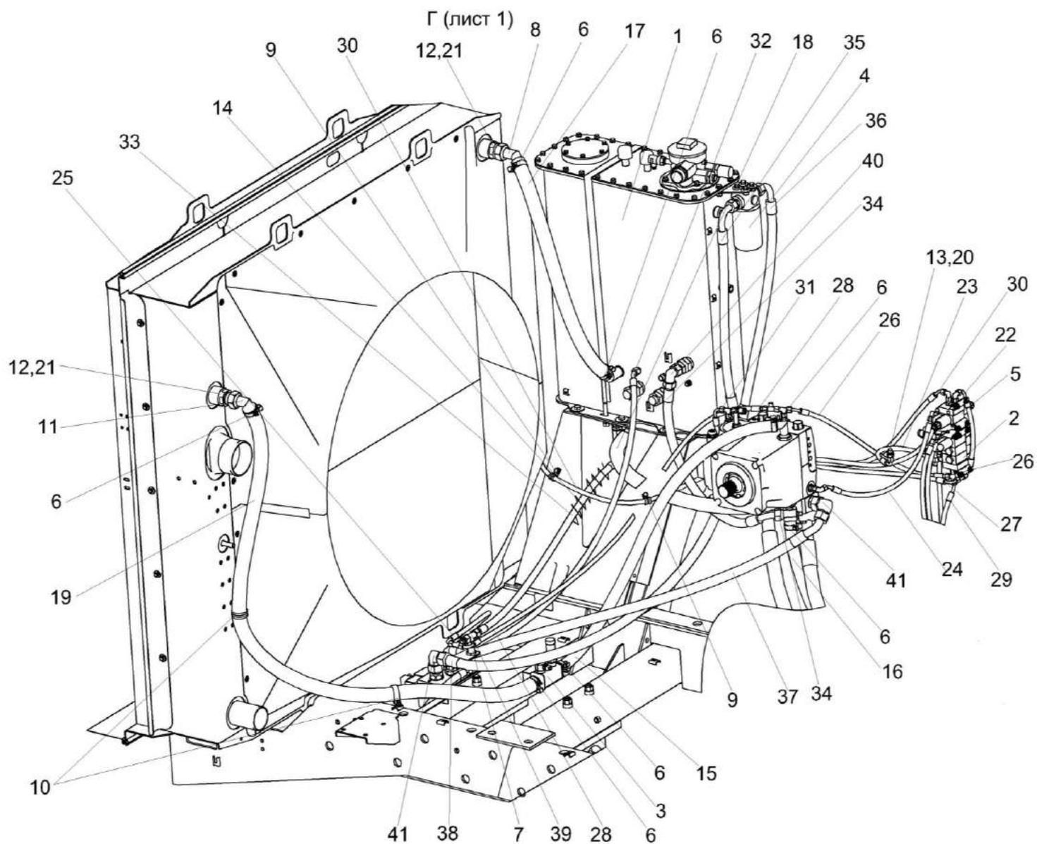
Рисунок 177 – Гидросистема привода ходовой части КВК-6-0601000 (лист 3)
