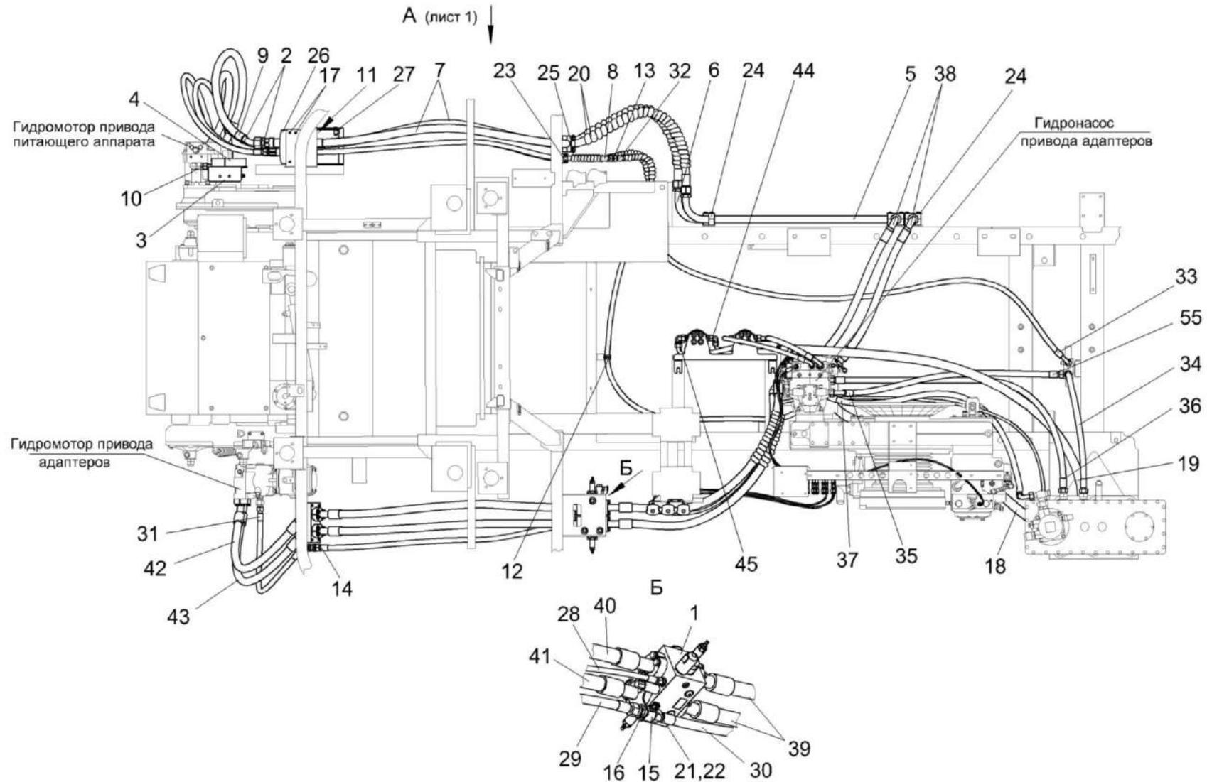
Рисунок 202 – Гидросистема привода питающего аппарата и адаптеров КВК-6-0604000 (лист 2)
