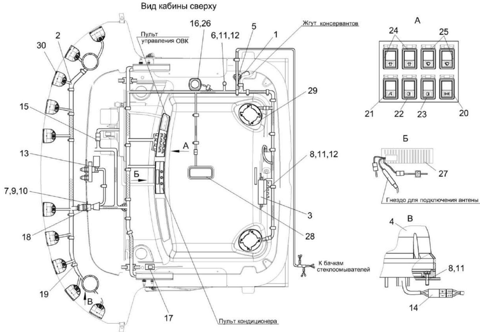
Рисунок 130 – Установка электрооборудования кабины КВК-6-0722000
