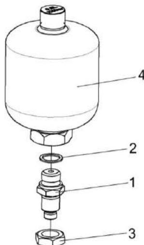
Рисунок 198 – Пневмогидроаккумулятор КВК 0602410
