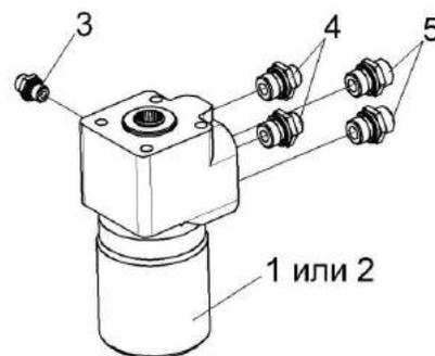
Рисунок 151 – Насос-дозатор КВК 0602130
