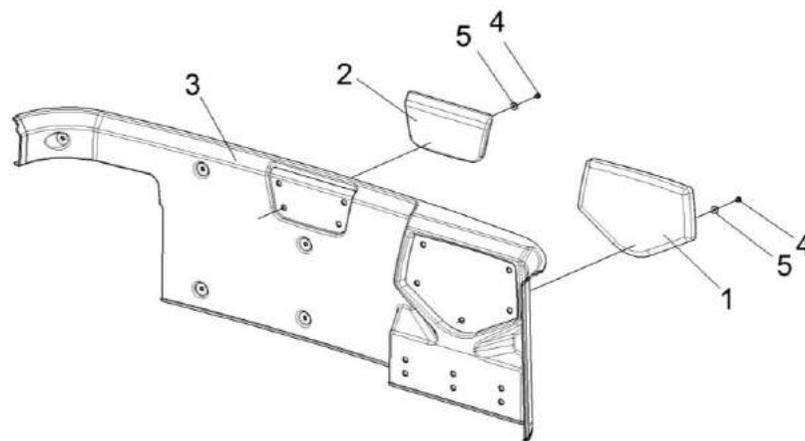
Рисунок 133 – Облицовка стенки КВК-6-0120240
