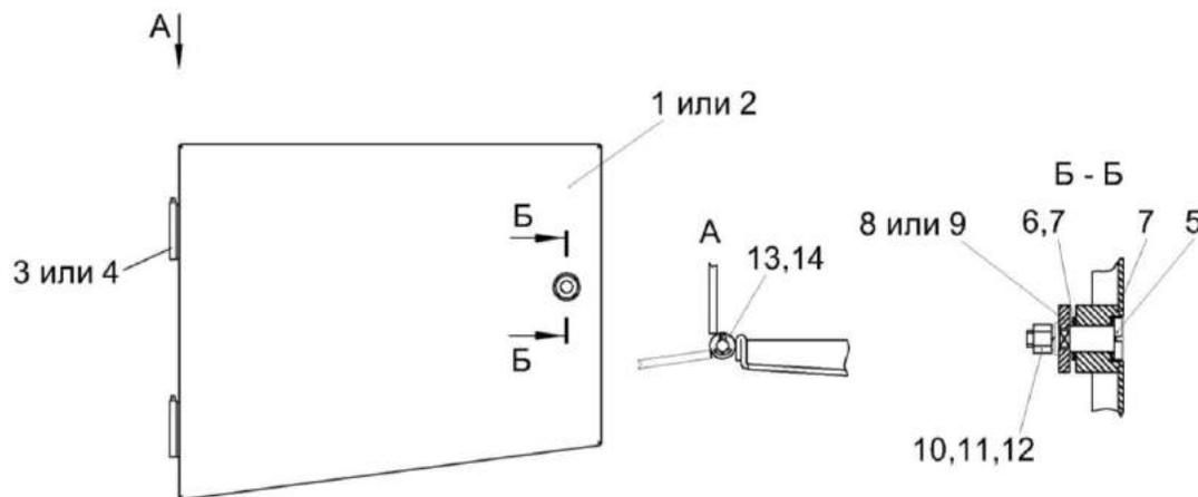
Рисунок 5 – Крышки КВК-6-0101030 и КВК-6-0101030-01
