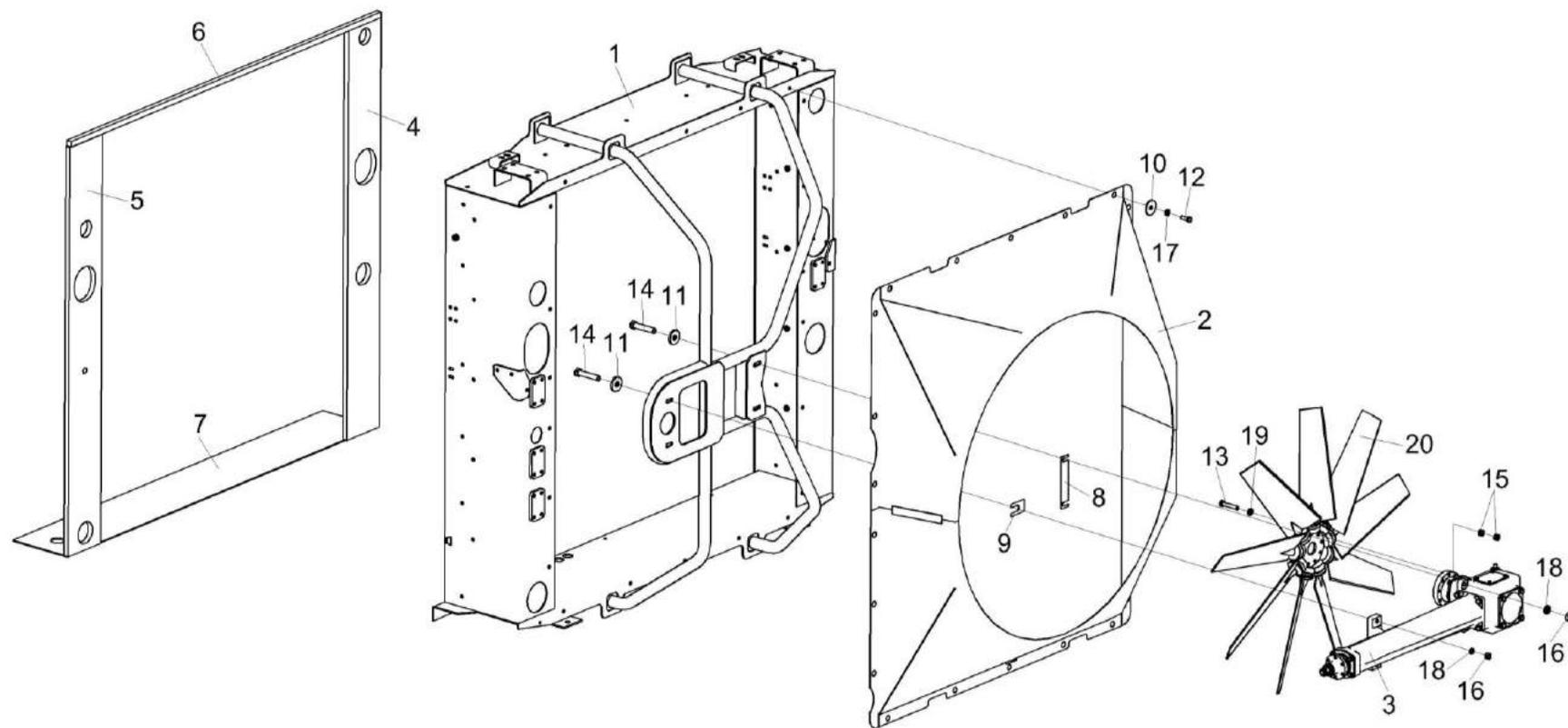
Рисунок 84 – Корпус радиаторов КВК-6-0152010
