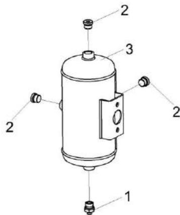
Рисунок 231 – Ресивер регенерации КВК-6-0800070
