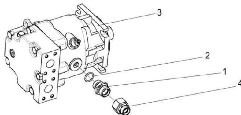
Рисунок 212 – Гидромотор привода адаптеров КВК 0604250
