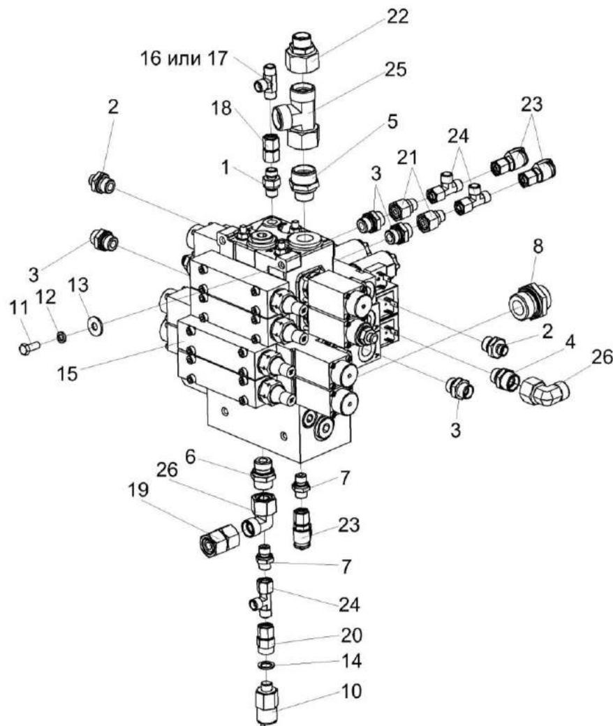
Рисунок 191 – Гидроблок навески КВК-6-0602300
