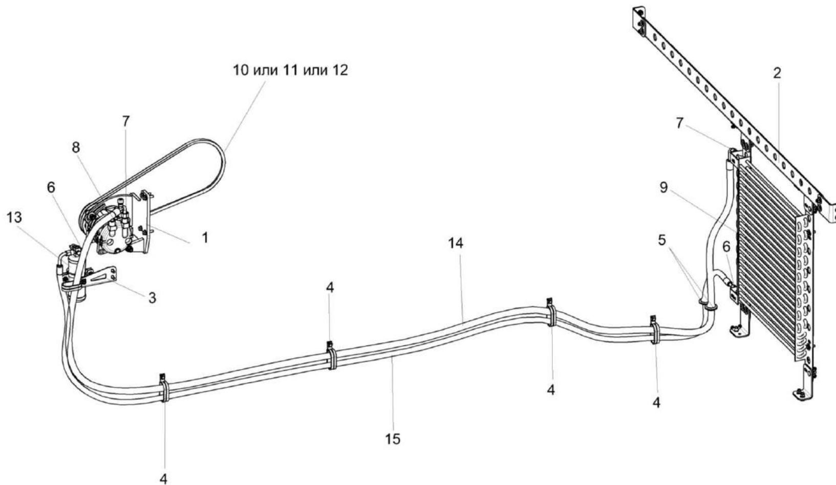
Рисунок 141 – Установка оборудования кондиционера КВК-6-0121010
