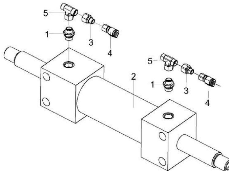
Рисунок 121 – Гидроцилиндр рулевого управления КВК-6-0602540
