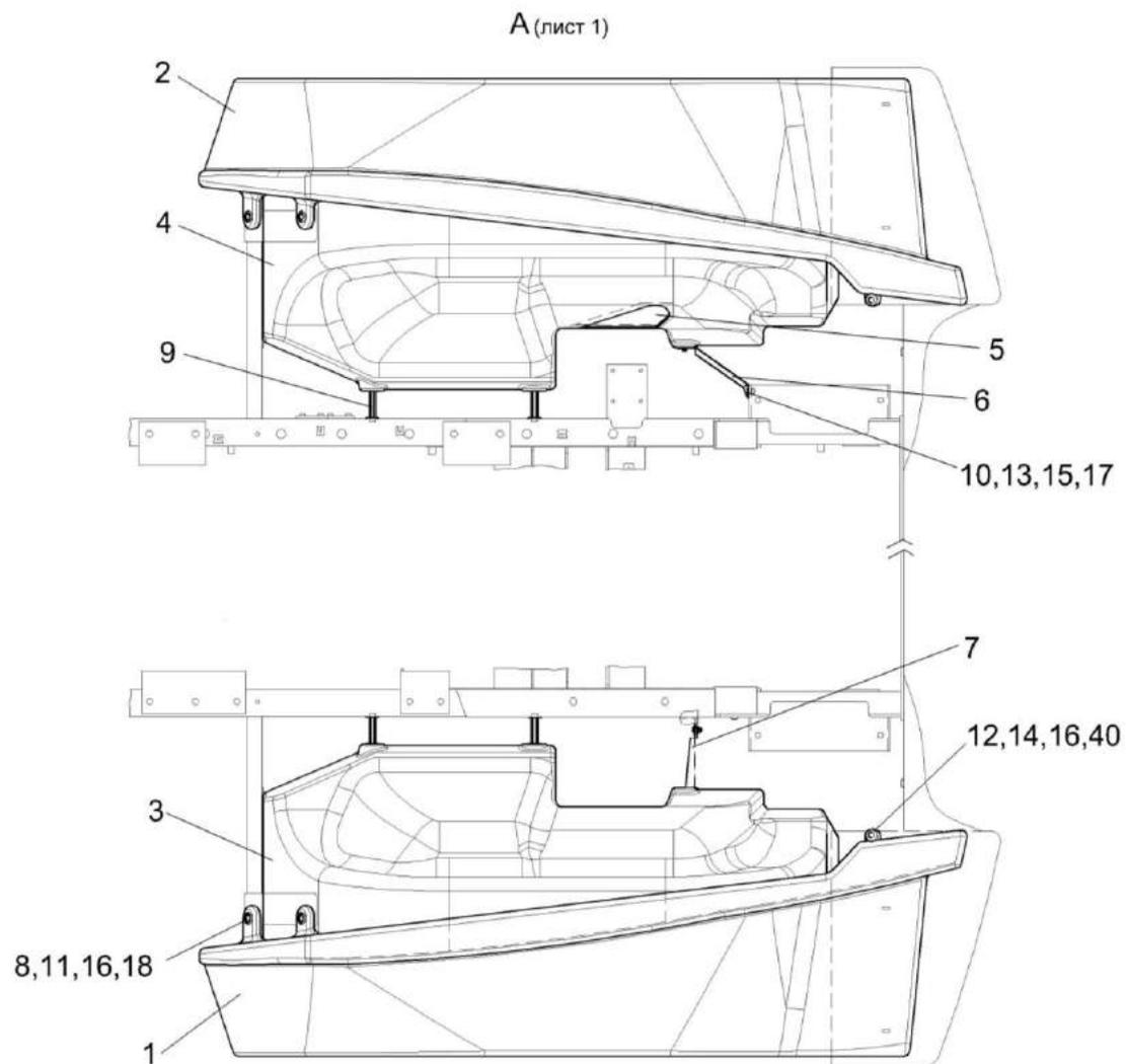
Рисунок 165 – Установка крыльев КВК-6-0161010 (лист 2)
