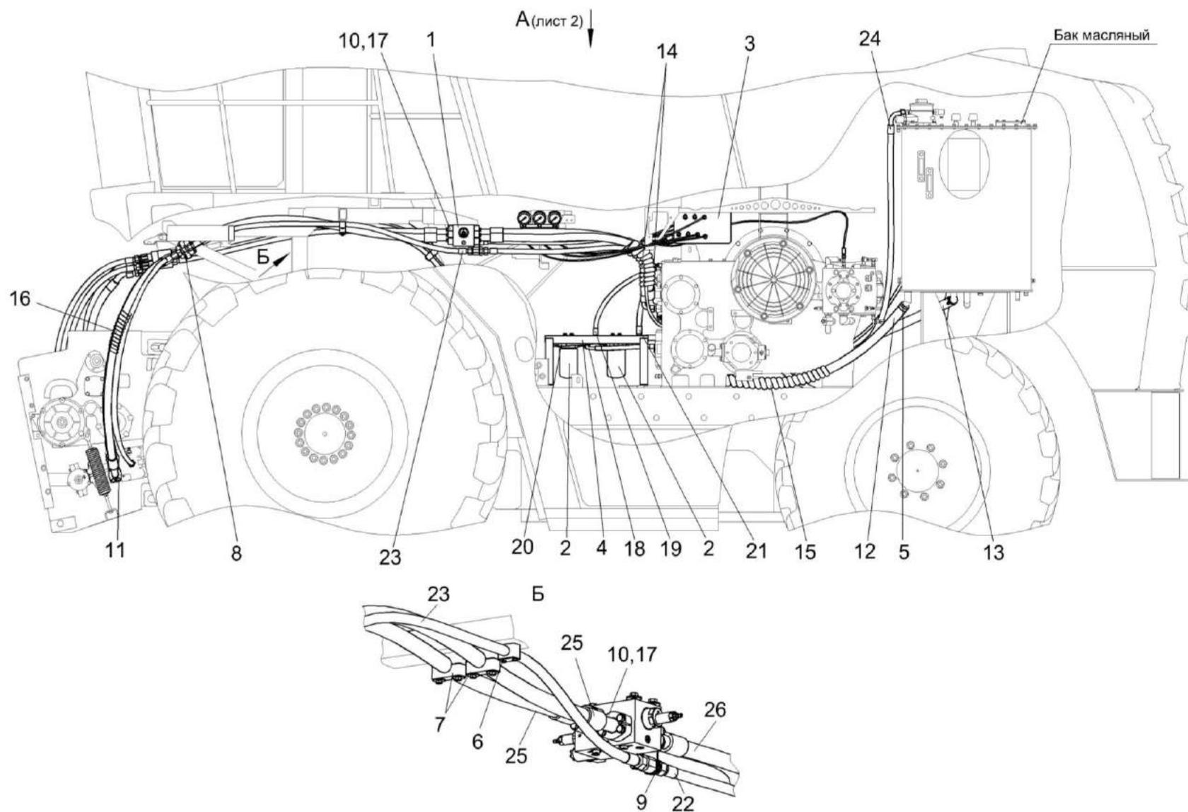
Рисунок 201 – Гидросистема привода питающего аппарата и адаптеров КВК-6-0604000
