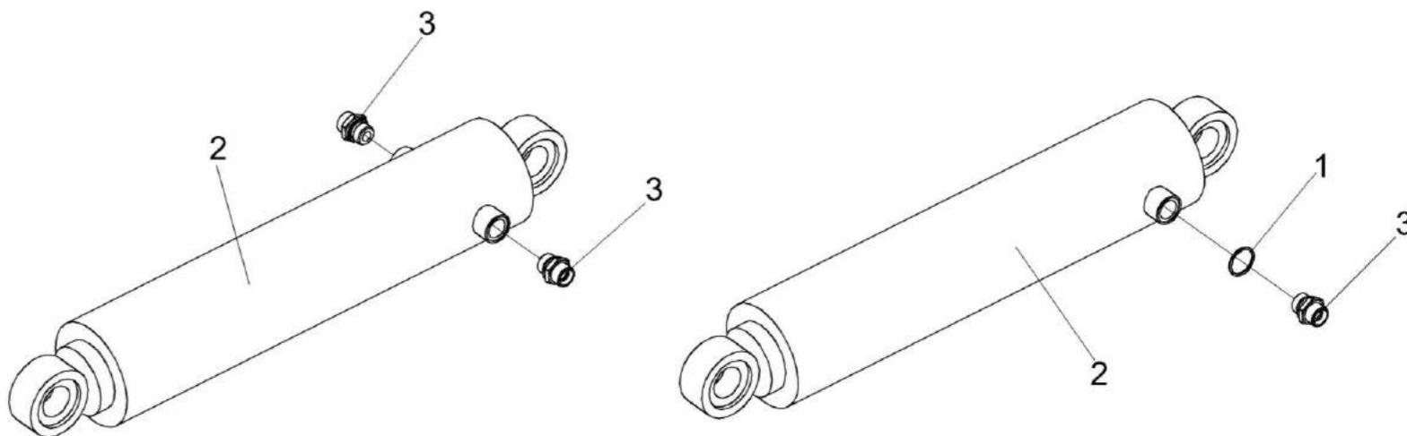
Рисунок 8 – Гидроцилиндры навески КВК 0602500Б и КВК 0602500Б-01
