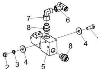
Рисунок 220 – Клапан электроуправляемый КВК 0606360А
