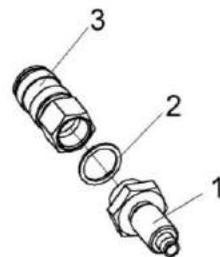
Рисунок 236 – Пневмовывод КНС-6028-0180110
