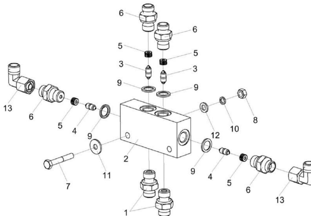
Рисунок 190 – Плита монтажная КВК-6-0602620
