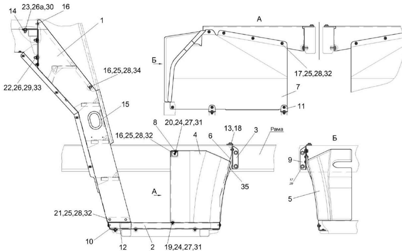
Рисунок 173 – Установка трапа и ограждений КВК-6-0175000
