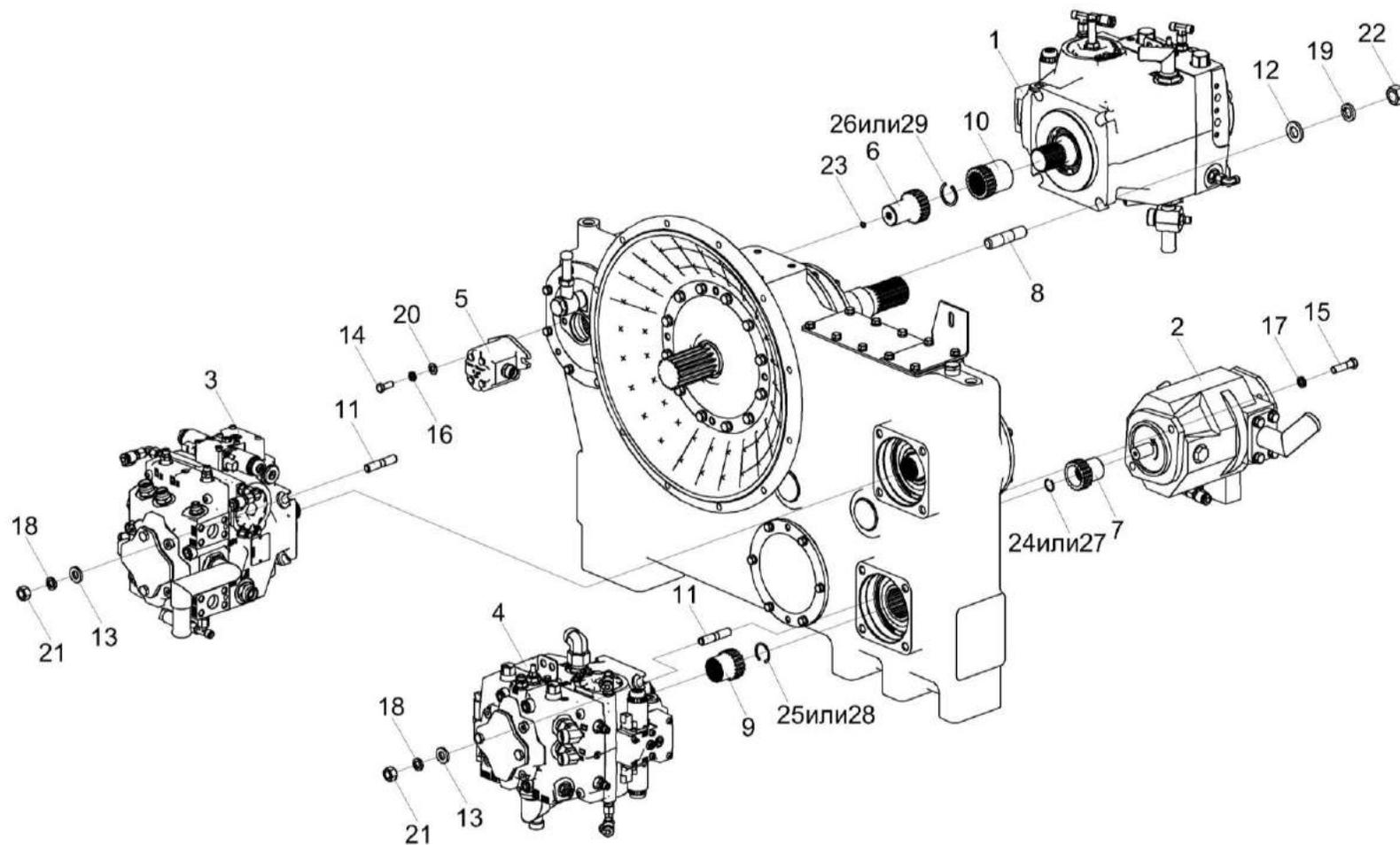
Рисунок 221 – Установка гидронасосов КВК-6-0138000
