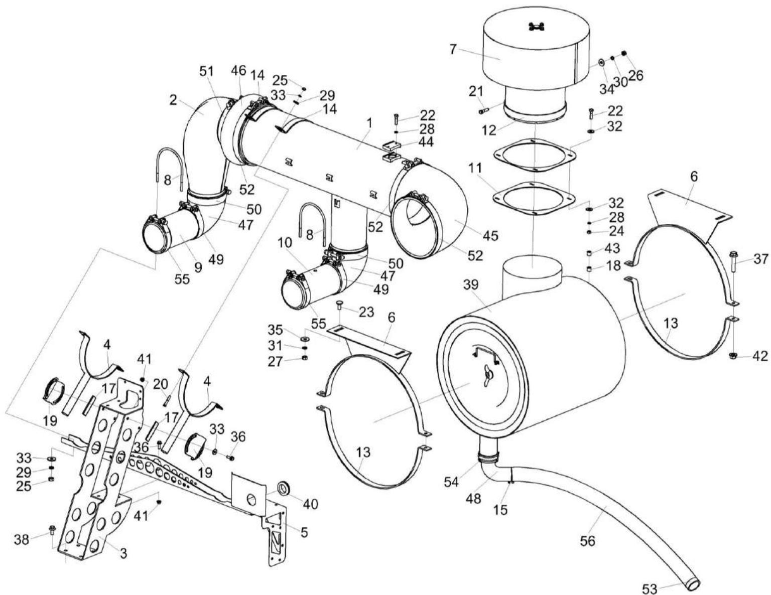
Рисунок 92 – Установка воздухоочистителя КВК-6-0153000
