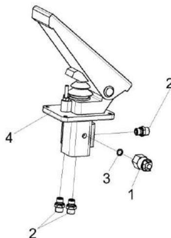
Рисунок 155 – Клапан тормозной КС-200-0606300
