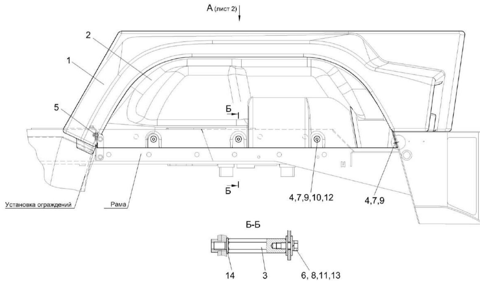
Рисунок 164 – Установка крыльев КВК-6-0161010 (лист 1)
