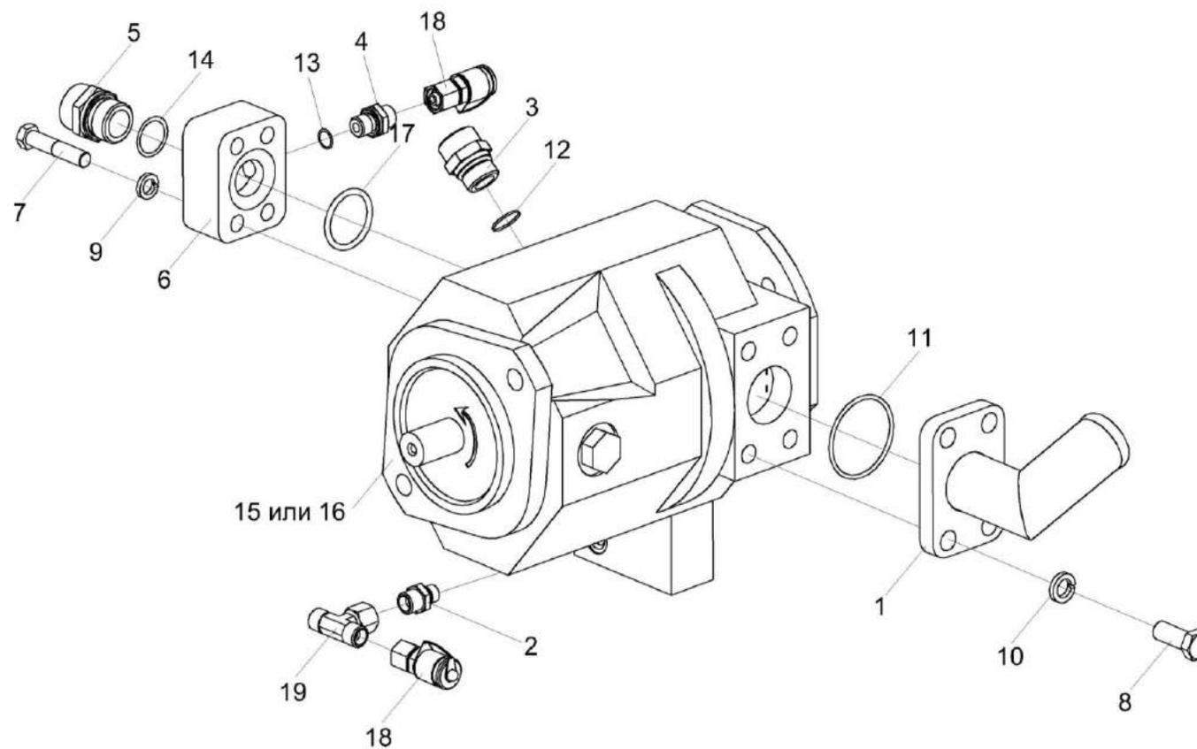
Рисунок 223 – Гидронасос рулевого управления КВК-6-0602200
