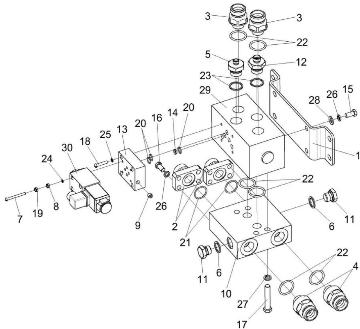
Рисунок 182 – Гидроблок подключения управляемого моста КВК 0601500
