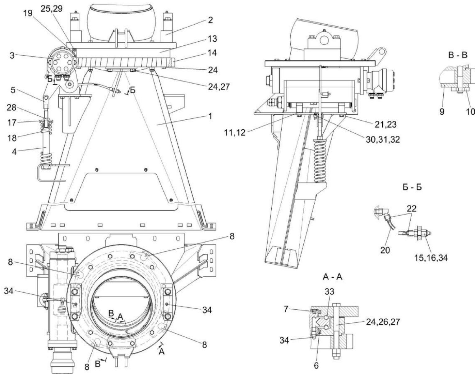
Рисунок 59 – Основание силопровода КВК 0143000
