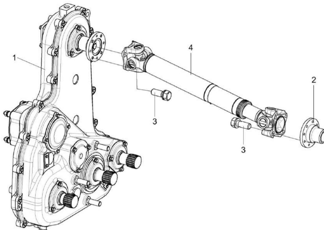
Рисунок 25 – Установка карданного вала
