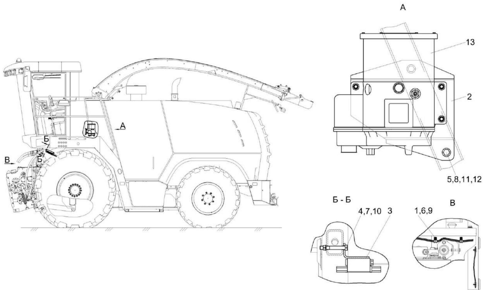
Рисунок 227 – Установка централизованной системы смазки КВК-6-0100600
