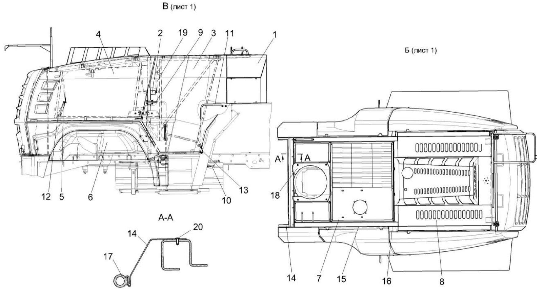
Рисунок 157 – Установка капотов КВК-6-0160000 (лист 2)
