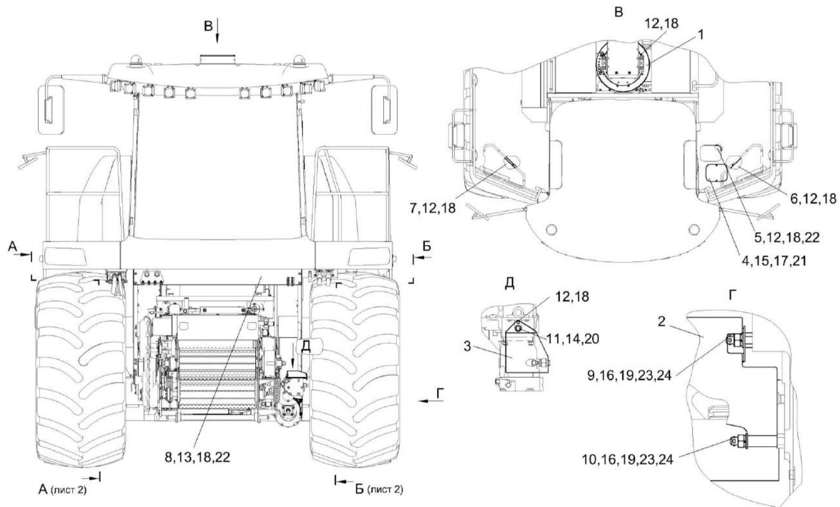
Рисунок 168 – Установка ограждений КВК-6-0100290 (лист 1)
