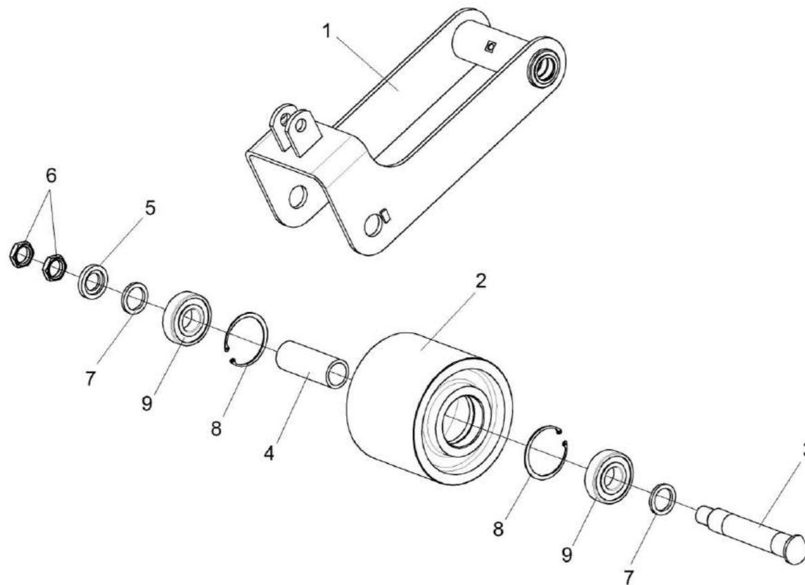
Рисунок 41 – Рычаг КВК-6-0130010
