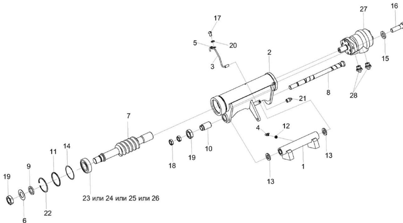
Рисунок 60 – Механизм поворота силосопровода КВК 0143150
