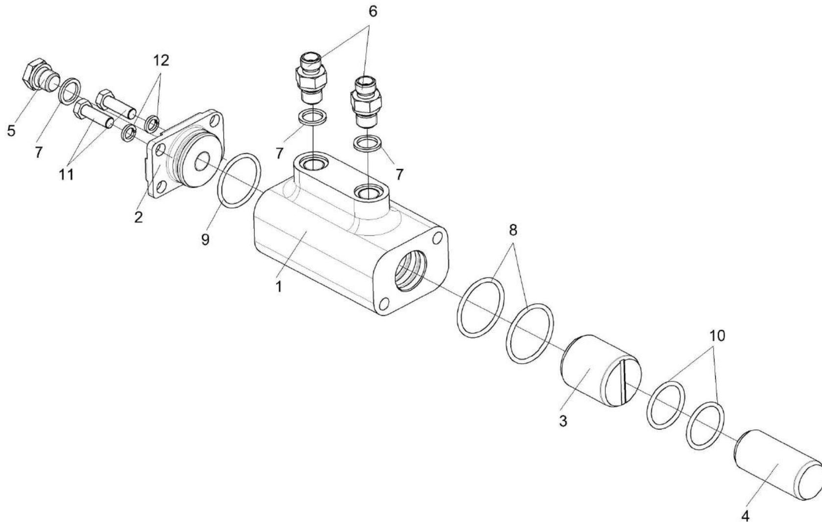
Рисунок 113 – Гидроцилиндр УЭС-16-5131010
