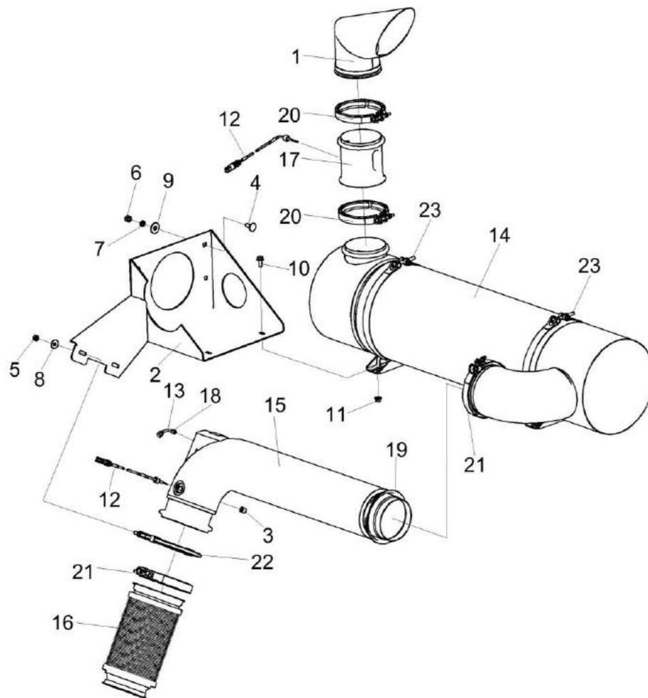
Рисунок 101 – Установка глушителя КВК-6-0157000
