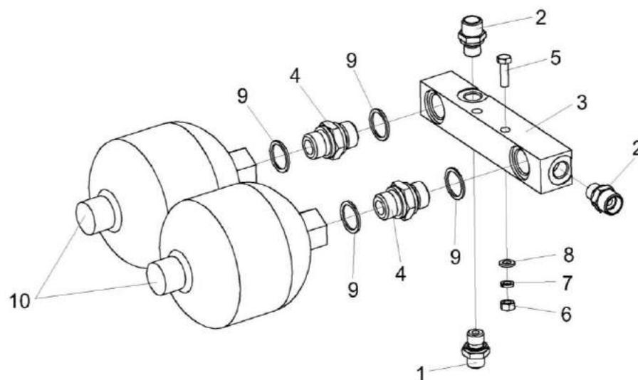
Рисунок 217 – Блок пневмогидроаккумуляторов КВК-6-0606370
