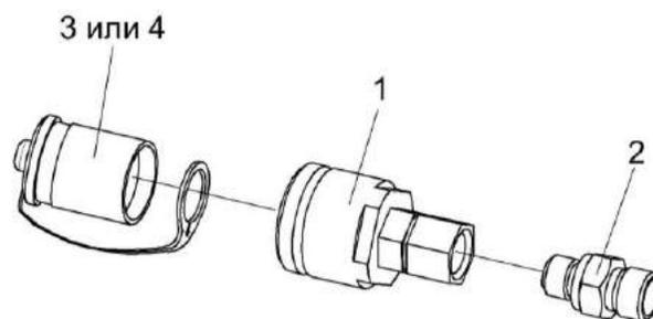
Рисунок 199 – Полумуфты КВК 0602660 и КВК 0602660-01
