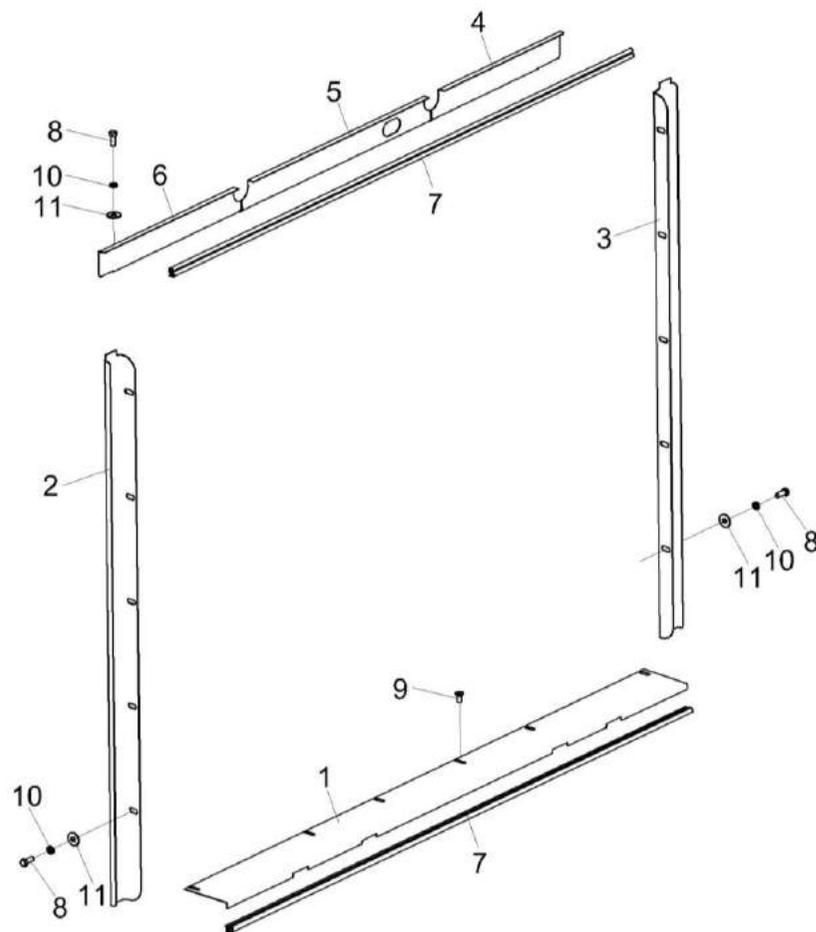
Рисунок 100 – Установка уплотнений КВК-6-0156000
