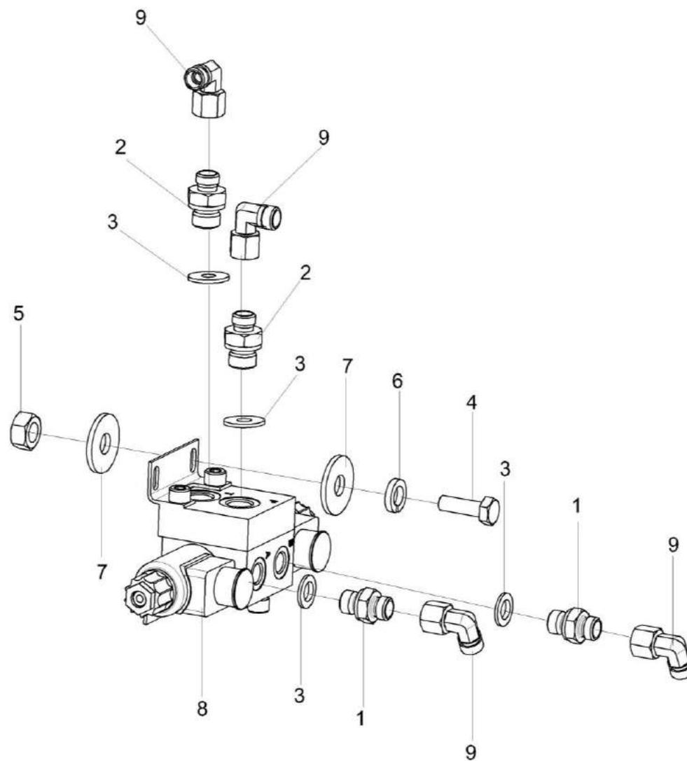
Рисунок 181 – Гидроблок доворота вала мотора ГСТ КВК-6-0601360
