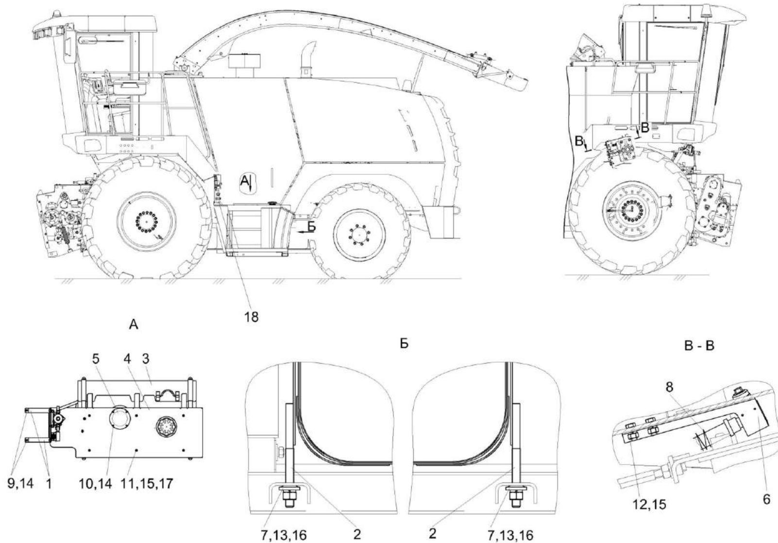
Рисунок 245 – Установка ОVK КВК-6-0100300
