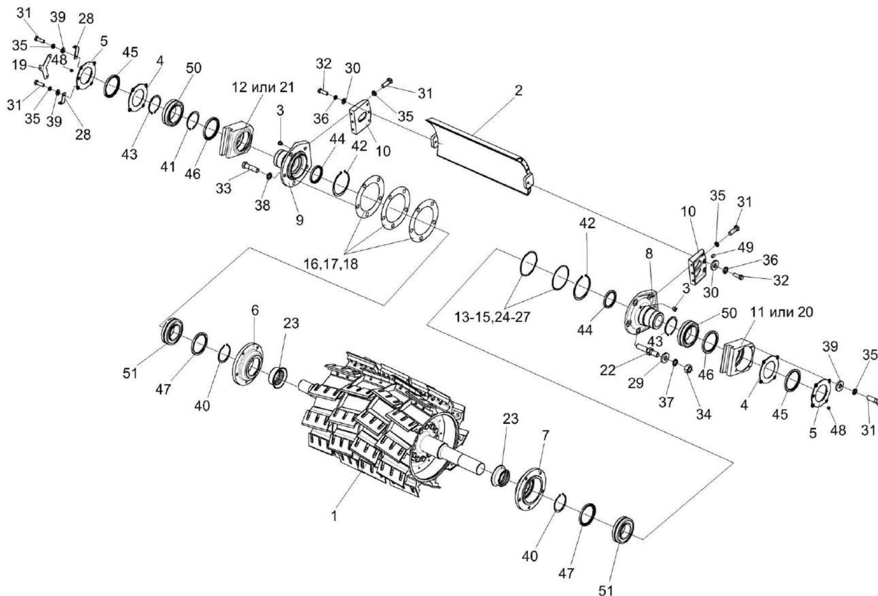
Рисунок 29 – Установка барабана КВК 0115020
