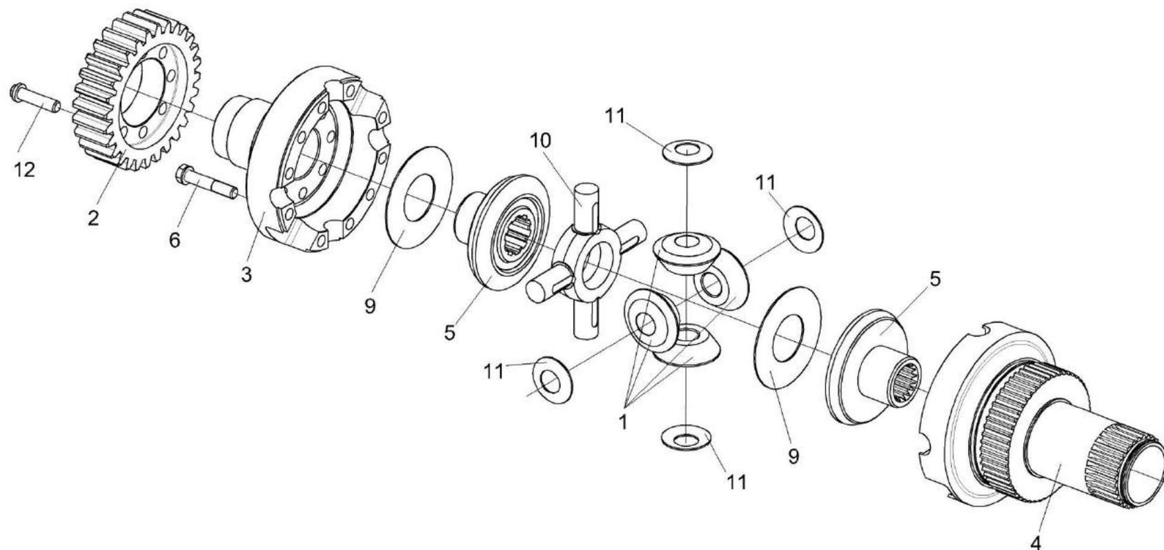
Рисунок 112 – Блок дифференциала КВК 0106200
