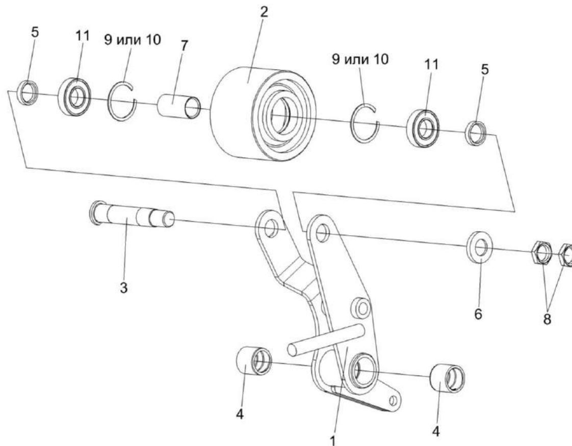
Рисунок 46 – Рычаг КВК 0131010
