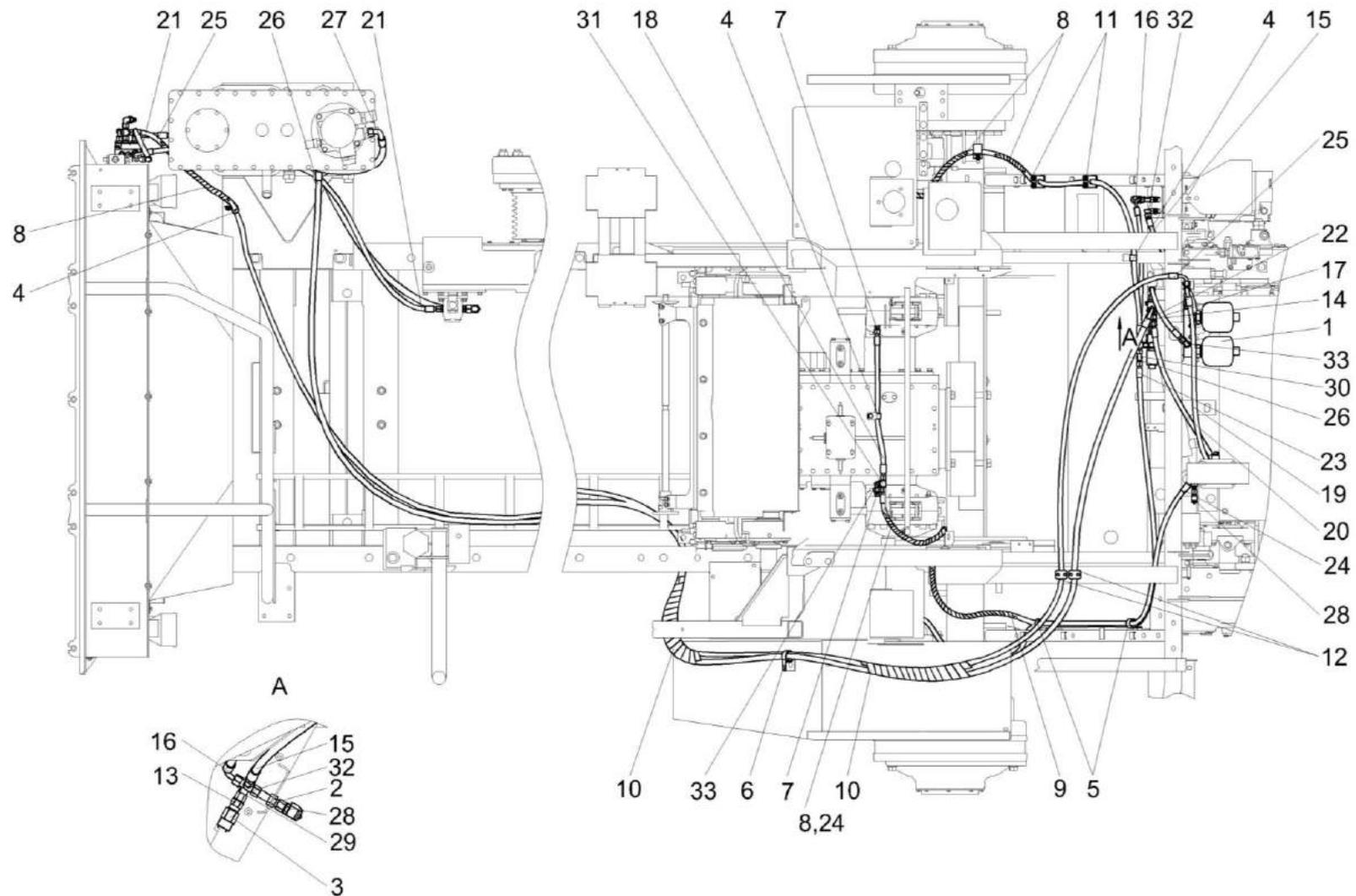
Рисунок 214 – Гидросистема привода стояночного и динамического тормозов КВК-6-0606000 (лист 1)
