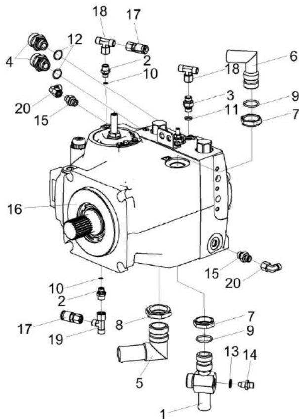
Рисунок 222 – Гидронасос КВК-6-0601100
