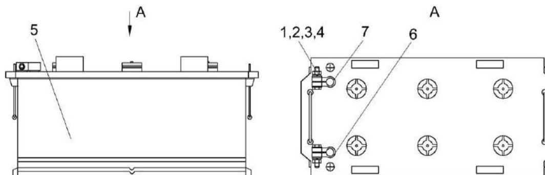
Рисунок 6 – Батарея аккумуляторная с переходниками КЗК0705190
