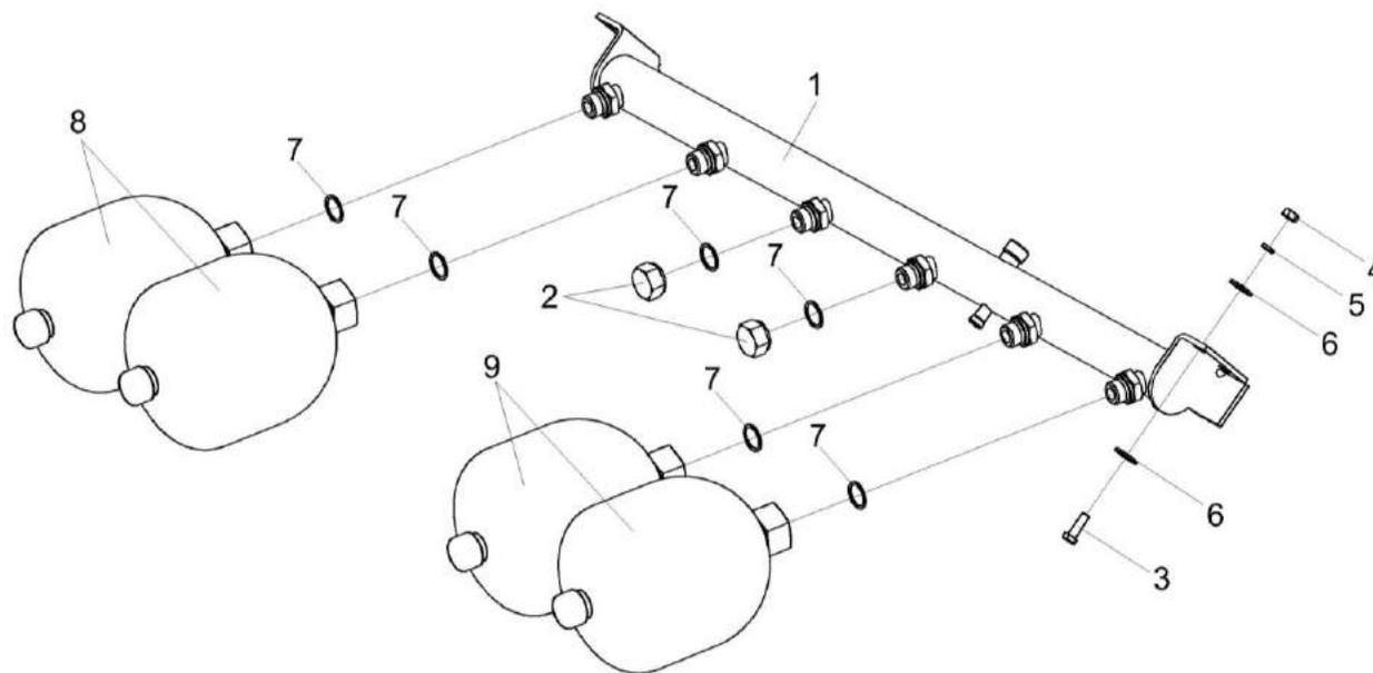
Рисунок 196 – Блок пневмогидроаккумуляторов КВК 0602350Б
