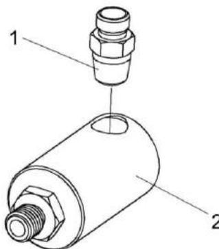
Рисунок 241 – Соединение ротационное КВК 0801040
