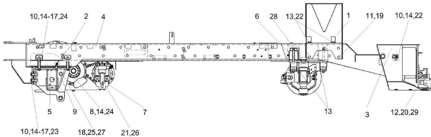
Рисунок 105 – Шасси КВК-6-0101000
