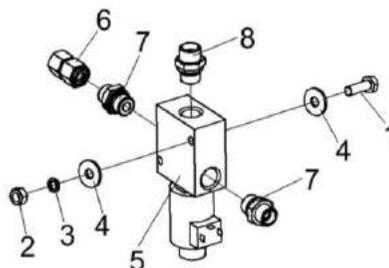
Рисунок 219 – Клапан электроуправляемый КВК 0606350А
