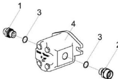
Рисунок 226 – Гидронасос КВК-6-0606100
