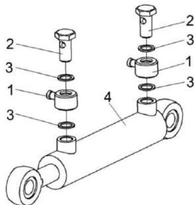
Рисунок 200 – Гидроцилиндр подъема силосопровода КВК 0602510А
