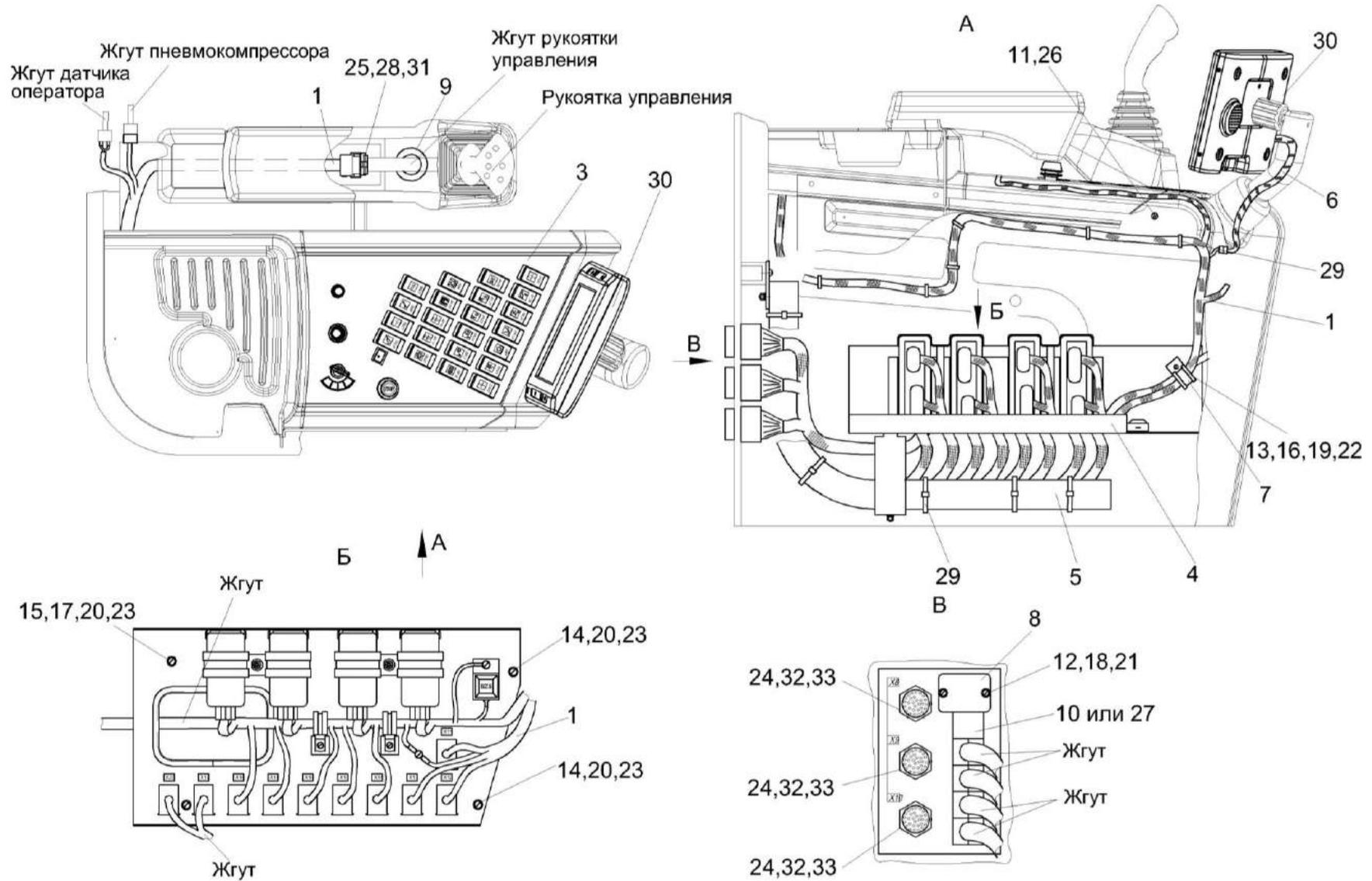
Рисунок 153 – Установка электрооборудования пульта управления КВК-6-0725000
