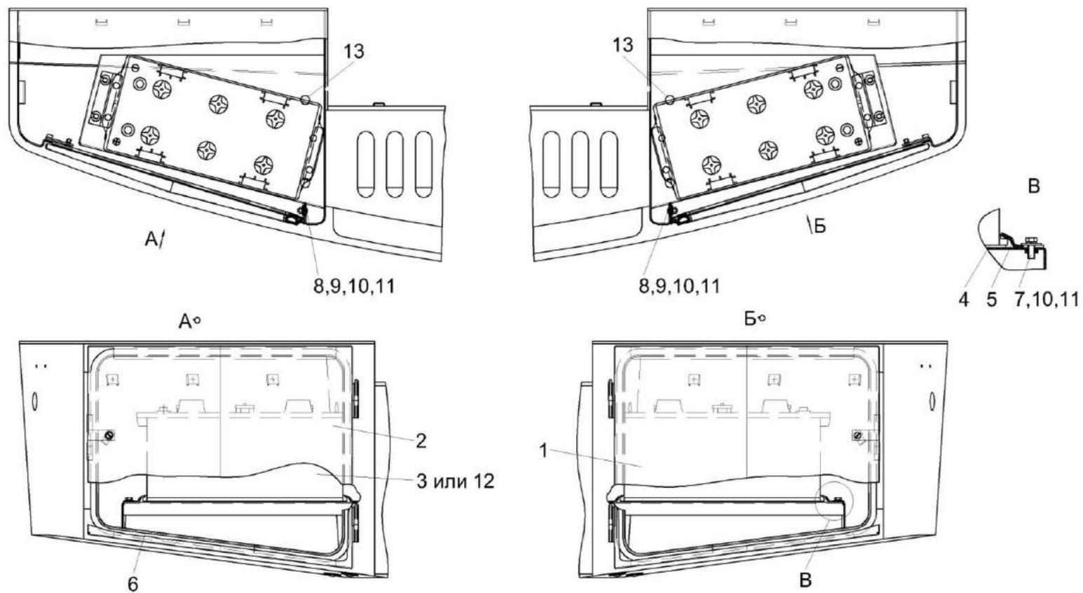
Рисунок 4 – Установка аккумуляторов КВК-6-0100020
