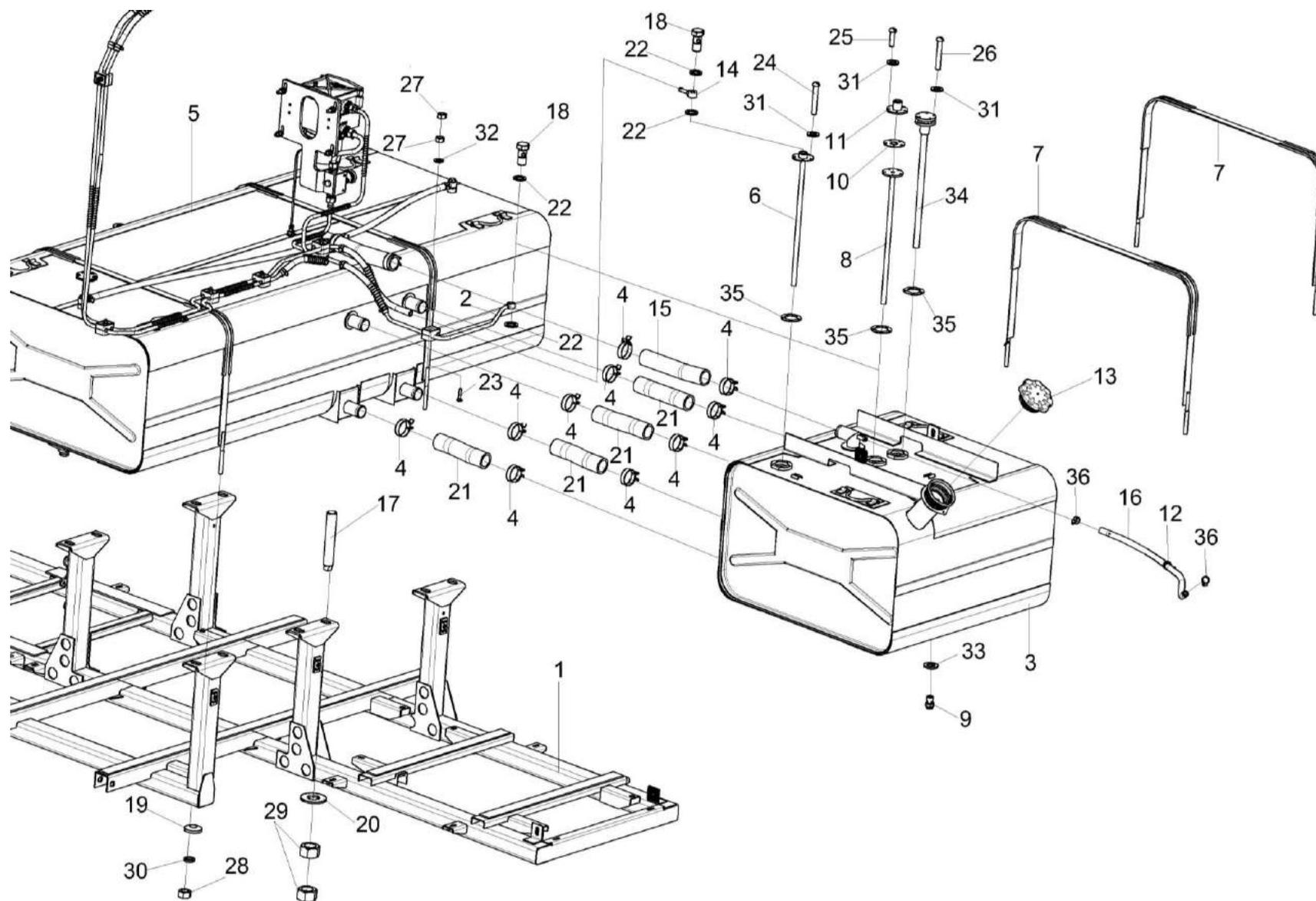
Рисунок 103 – Установка топливного оборудования КВК-6-0103000 (лист 2)
