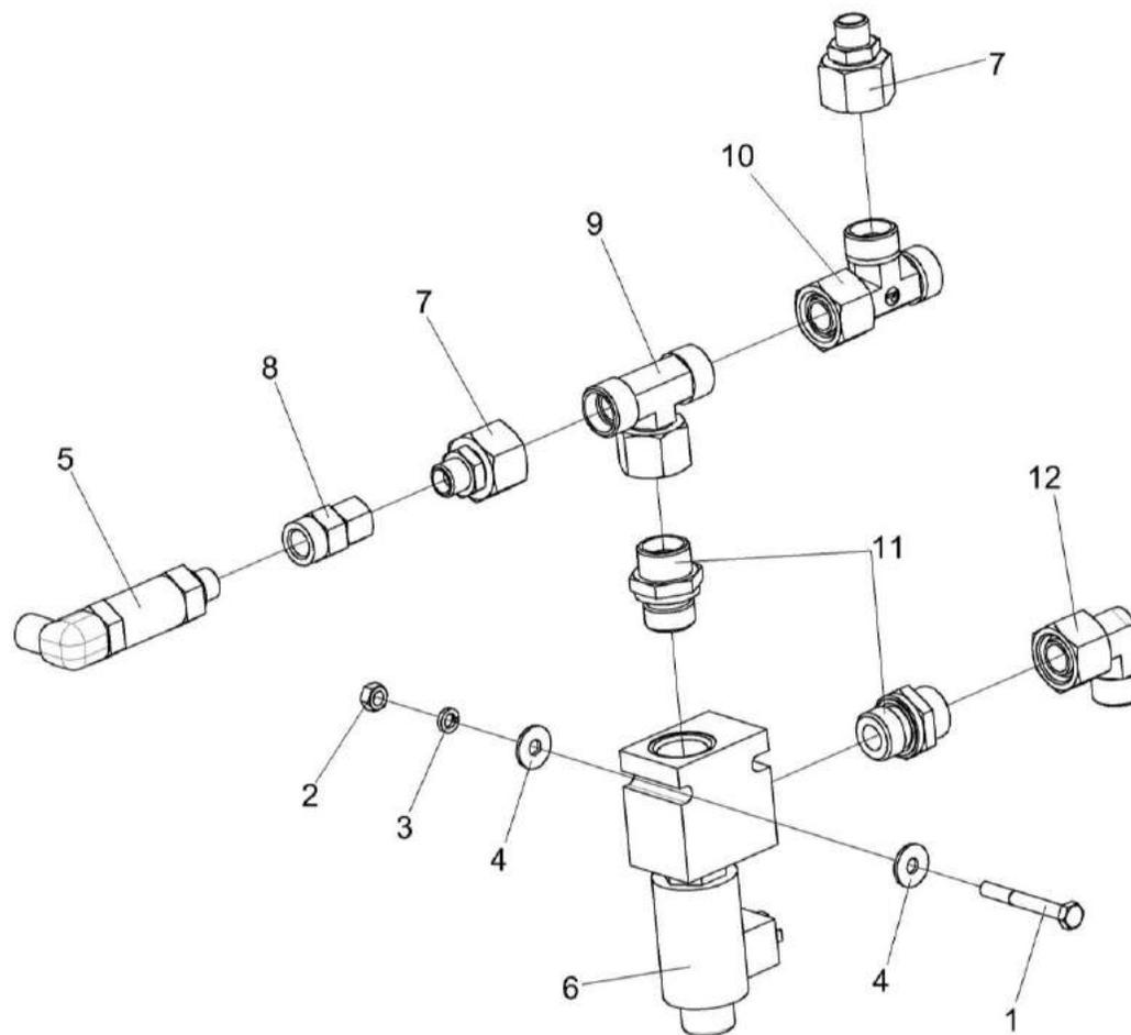
Рисунок 195 – Клапан блока пневмогидроаккумуляторов КВК 0602330Б
