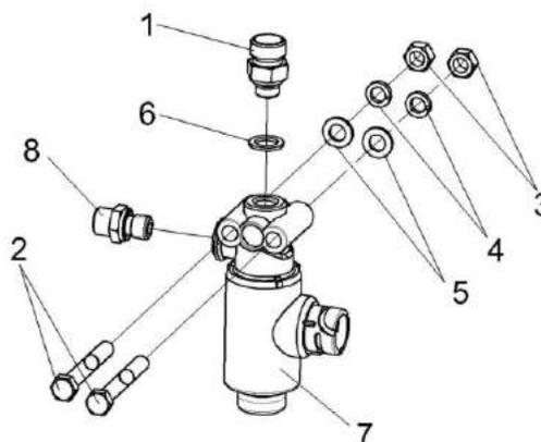
Рисунок 239 – Клапан электромагнитный КВК-6-0801040
