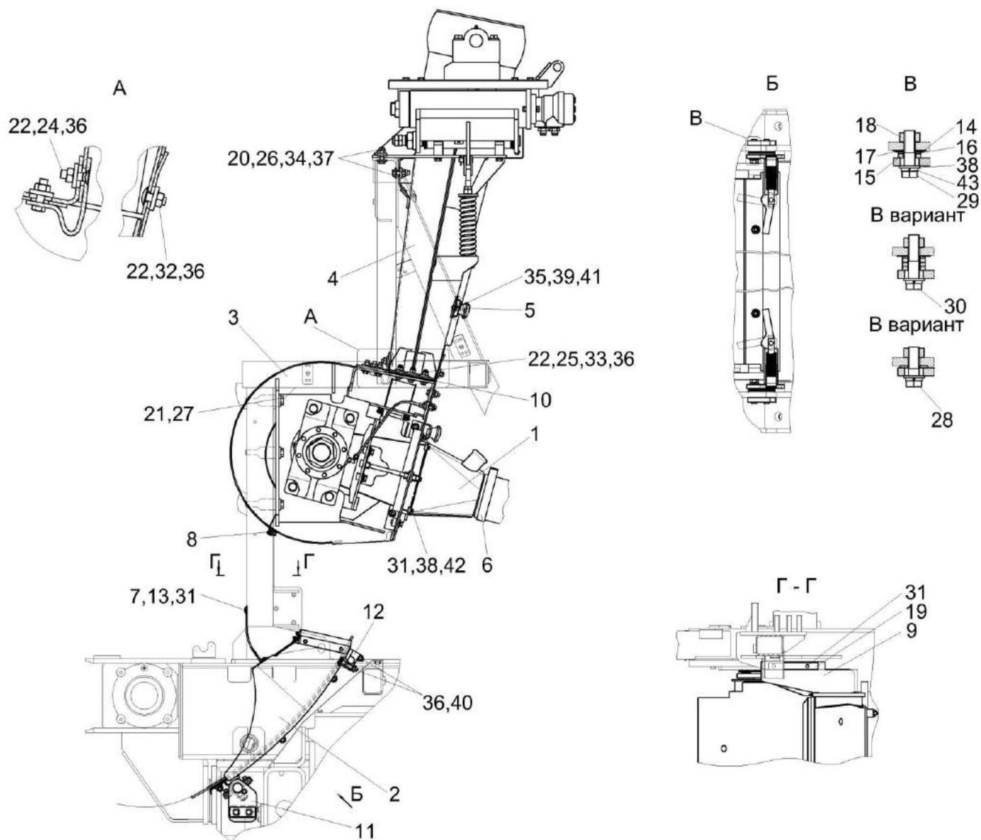
Рисунок 53 – Установка ускорителя выброса, камеры приемной и основания силосопровода КВК-6-0140000
