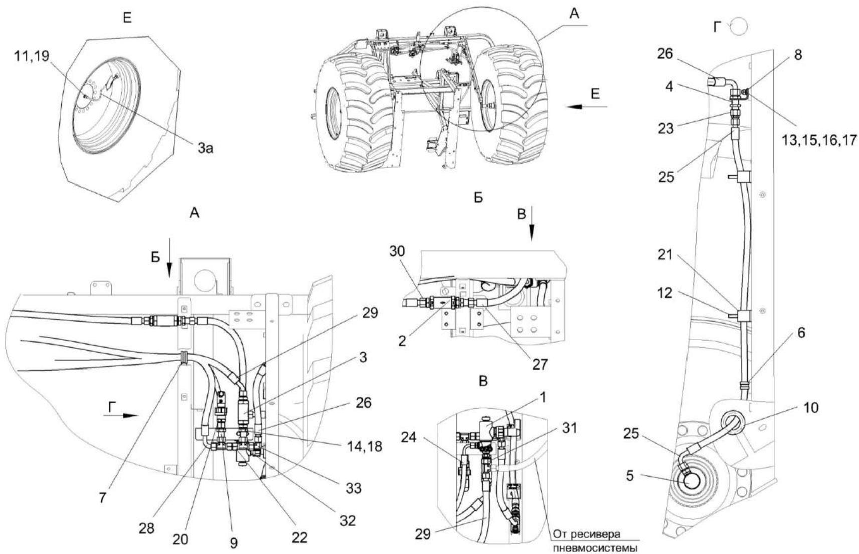
Рисунок 237 – Пневмосистема подкачки шин КВК-6-0801000 (лист 1)
