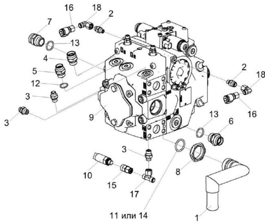
Рисунок 224 – Гидронасос привода адаптеров КВК-6-0604110
