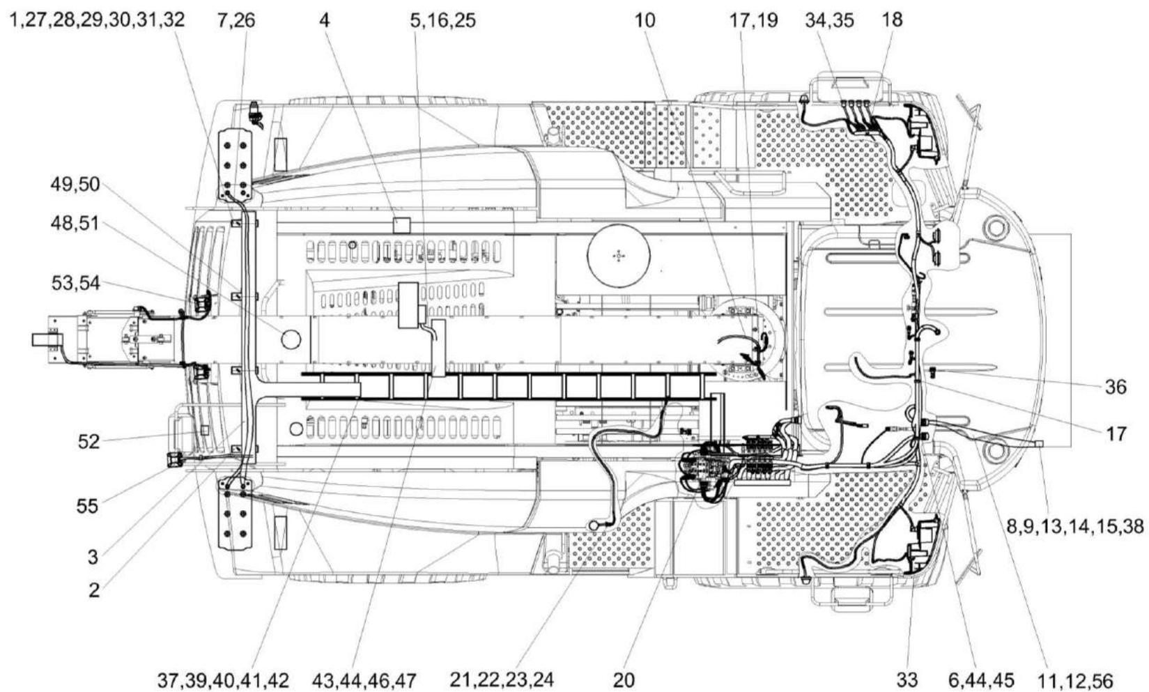
Рисунок 242 – Электрооборудование измельчителя самоходного КВК-6-0721000 (лист 1)
