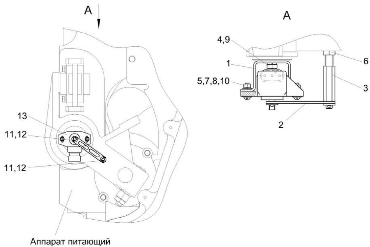
Рисунок 39 – Установка датчика положения КВК 0111800
