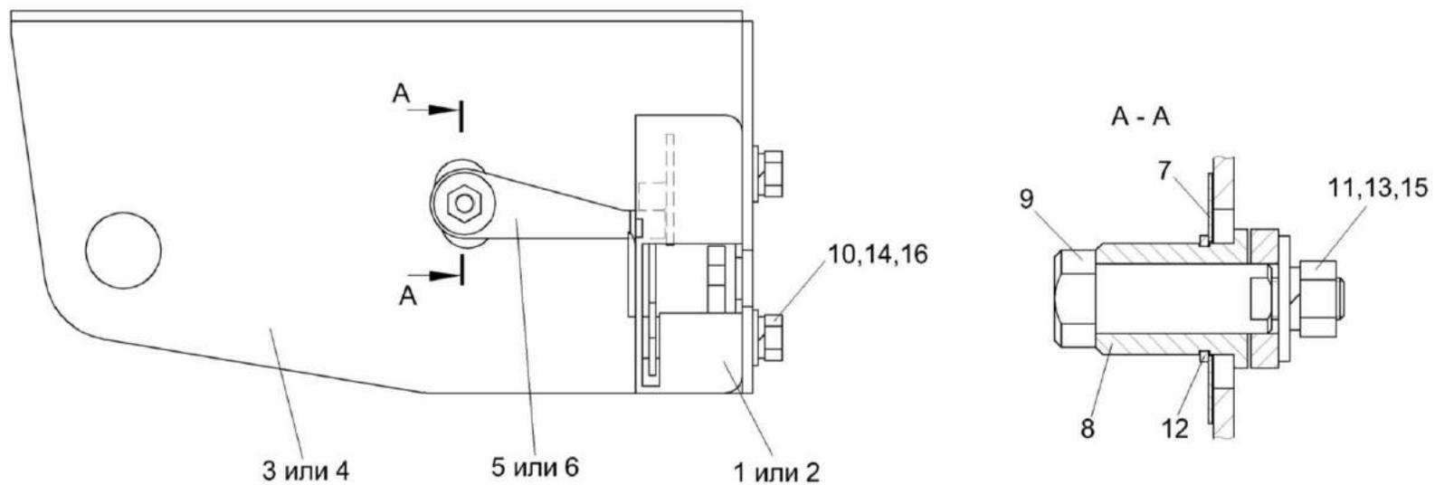
Рисунок 162 – Замки КВК 0160240 и КВК 0160240-01
