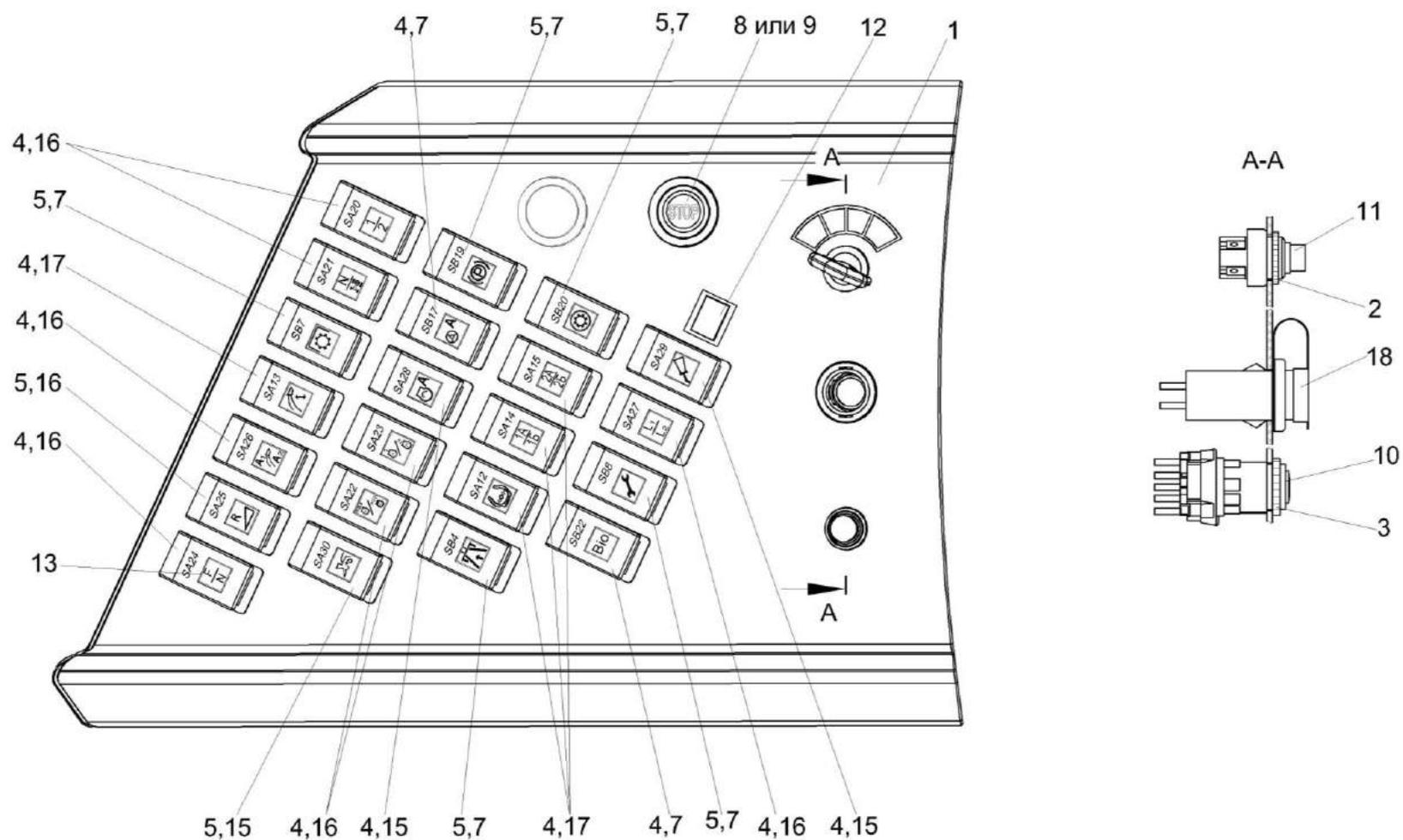
Рисунок 154 – Панель выключателей КВК-6-0700450
