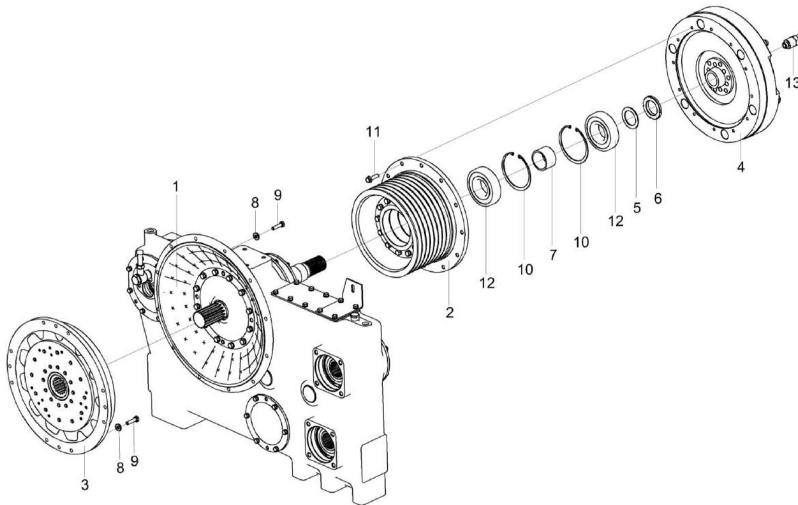
Рисунок 73 – Установка главного привода КВК-6-0151000
