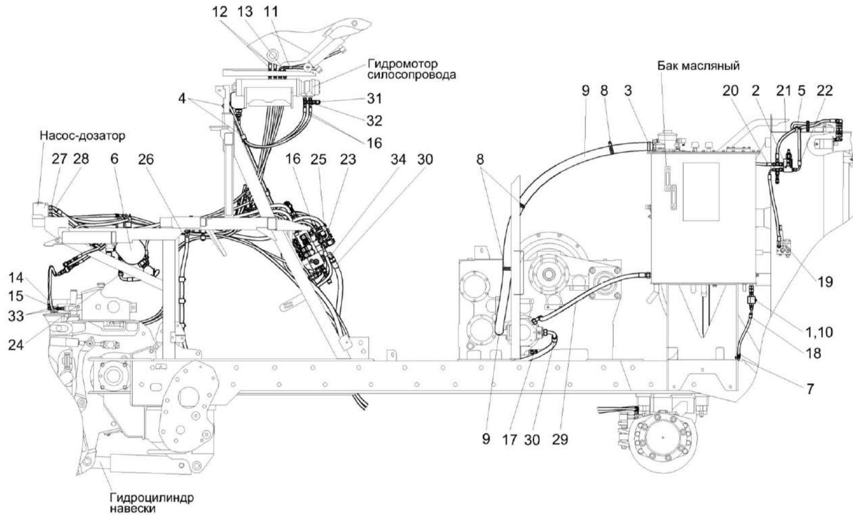
Рисунок 186 – Гидросистема рулевого управления и силовых гидроцилиндров КВК-6-0602000 (лист 3)
