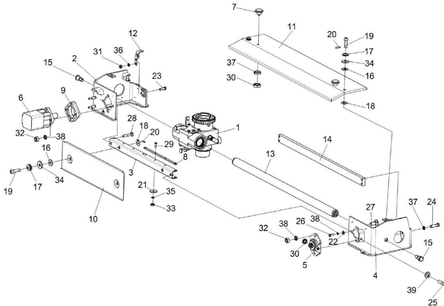
Рисунок 33 – Устройство заточное КВК 0116000
