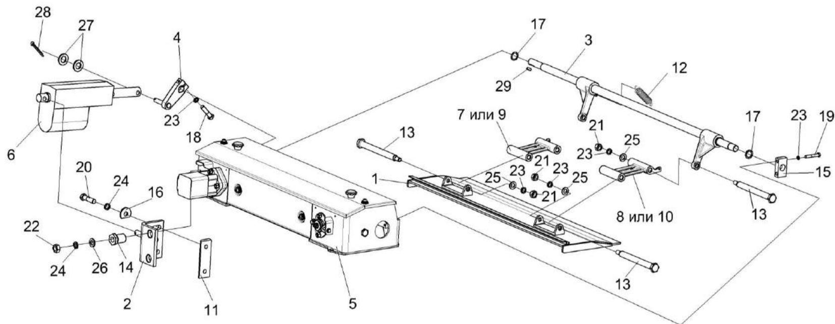
Рисунок 11 – Установка привода КВК 0110250
