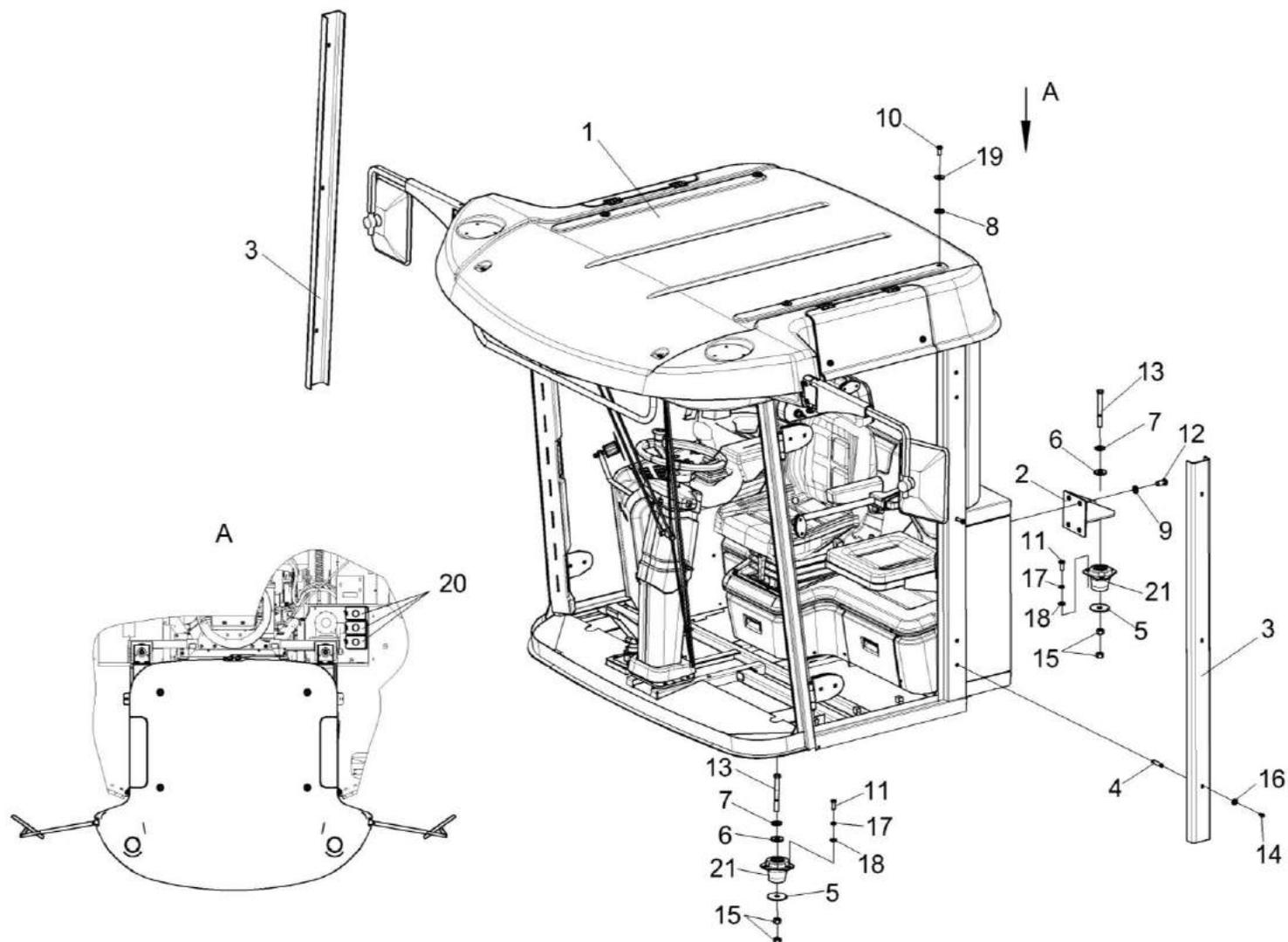
Рисунок 126 – Установка кабины КВК-6-0120000
