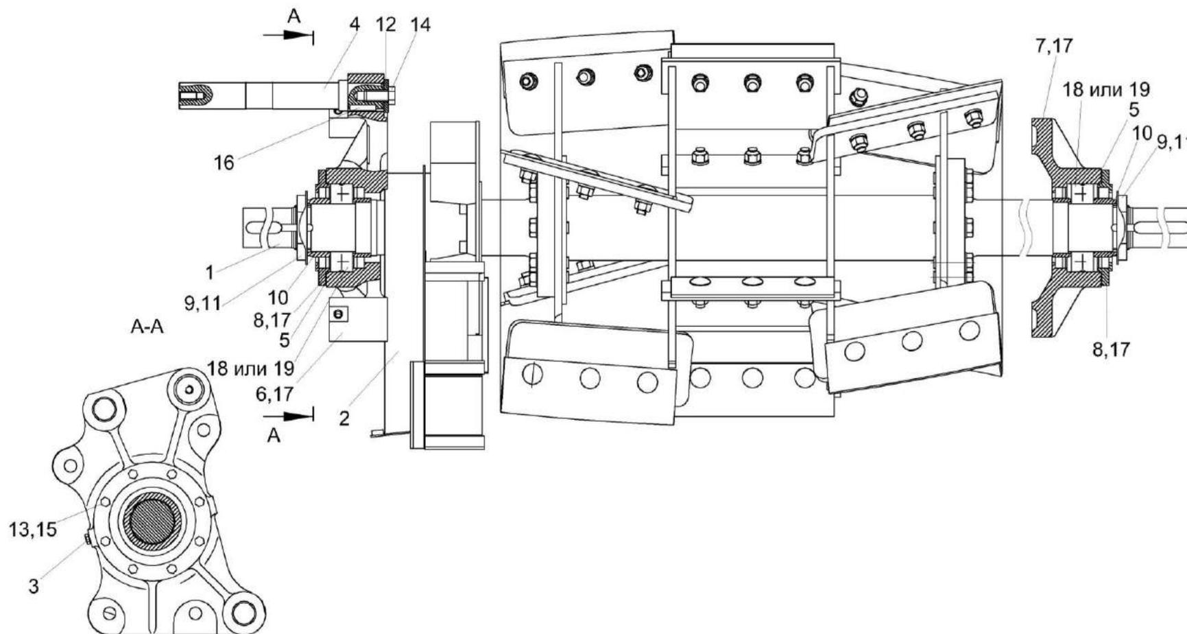
Рисунок 57 – Вал ускорителя выброса КВК-6-0142400
