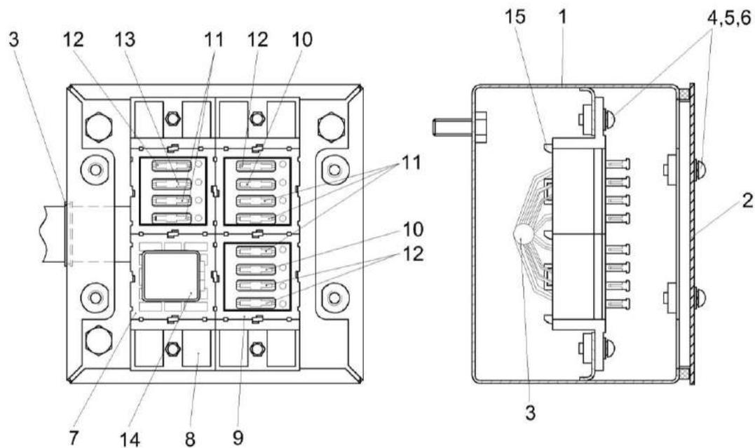
Рисунок 244 – Блок коммутации КВК-6-0700030
