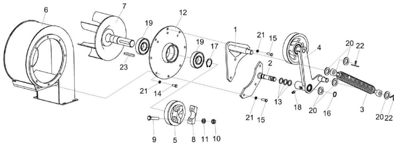
Рисунок 97 – Вентилятор КВК-6-0155800
