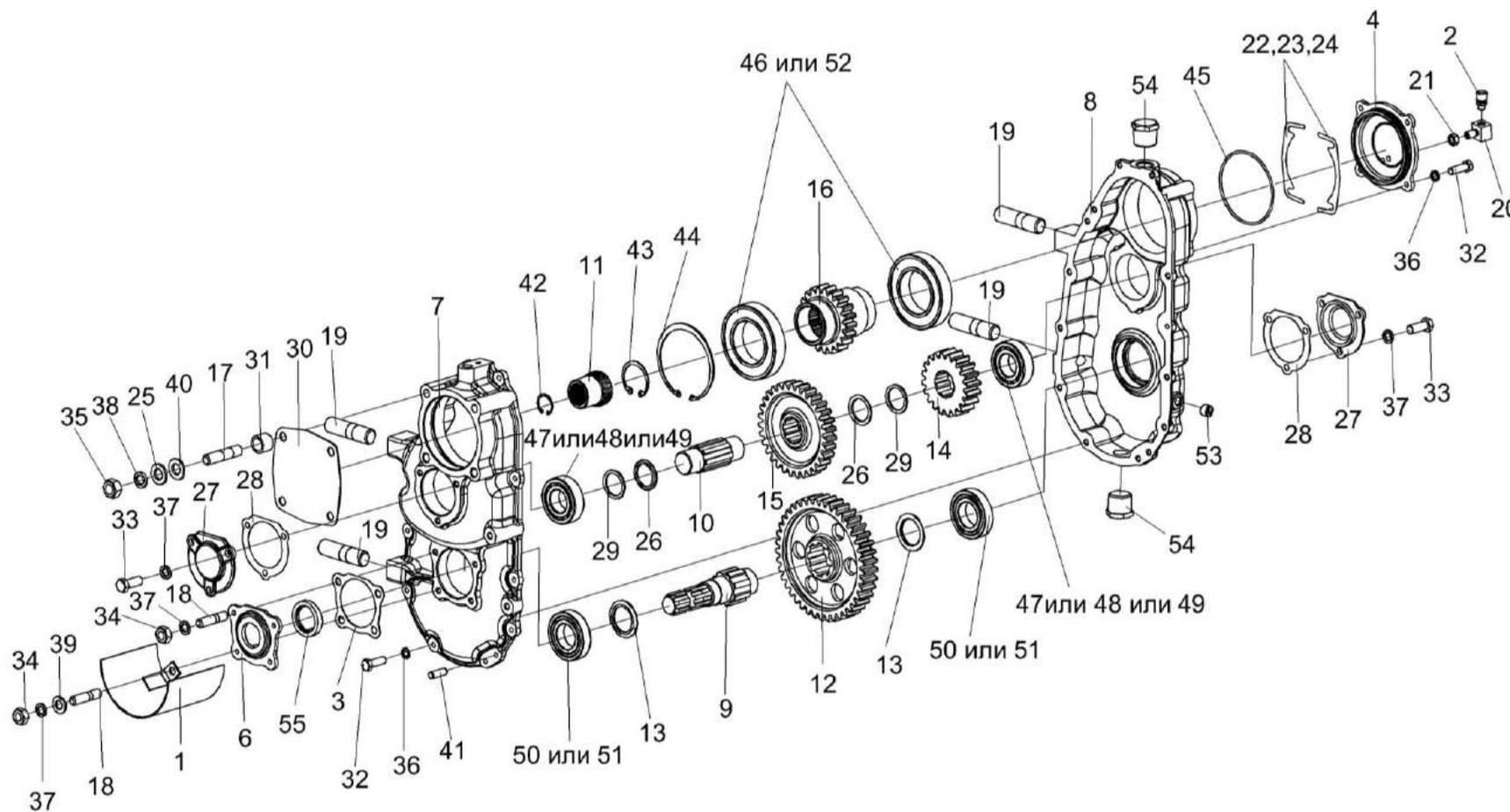
Рисунок 43 – Редуктор КВК 0104100А
