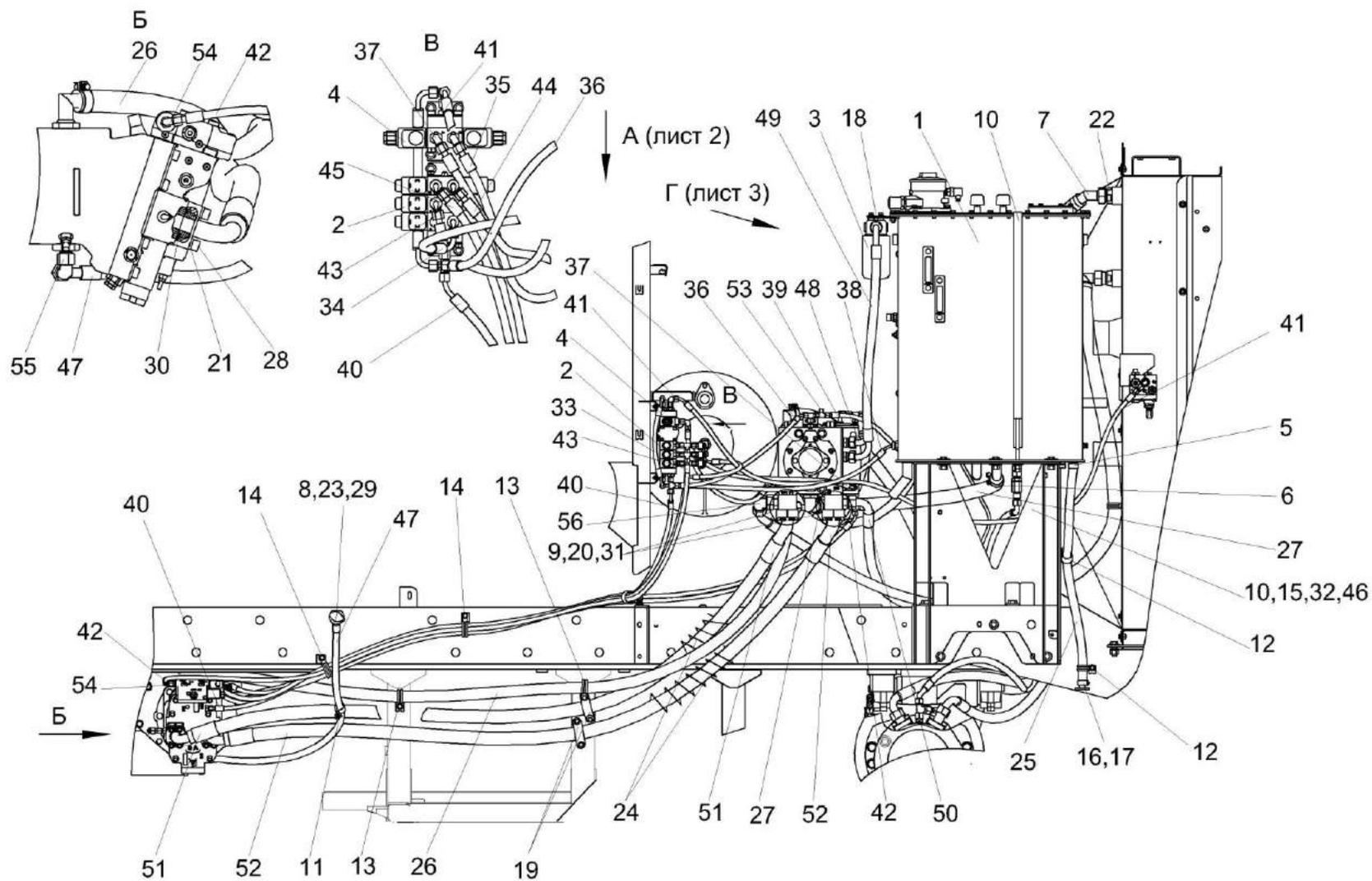
Рисунок 175 – Гидросистема привода ходовой части КВК-6-0601000 (лист 1)
