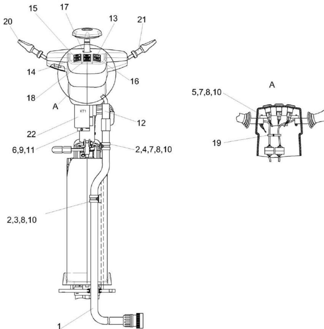
Рисунок 150 – Установка электрооборудования рулевой колонки КВК-6-0723000
