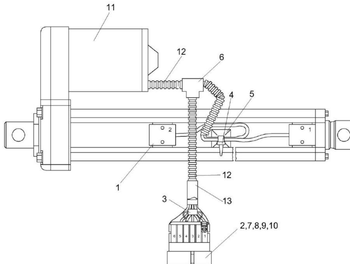
Рисунок 37 – Электромеханизм крышки заточного устройства КВК 0701610
