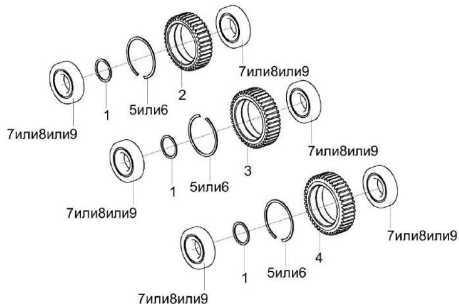
Рисунок 78 – Шестерни КВК 0137150, КВК 0137160, КВК 0137170
