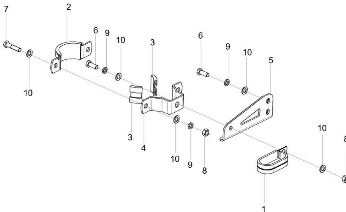
Рисунок 143 – Установка ресивера КВК-6-0121060
