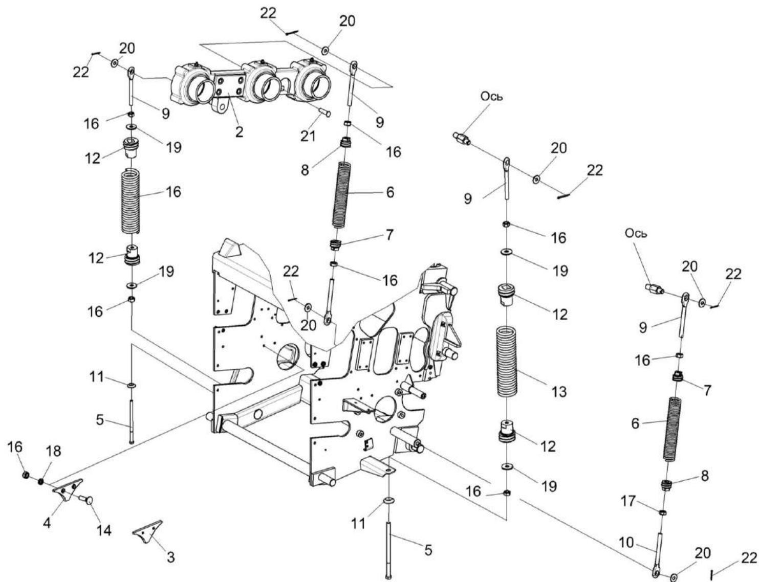
Рисунок 24 – Пружины аппарата питающего
