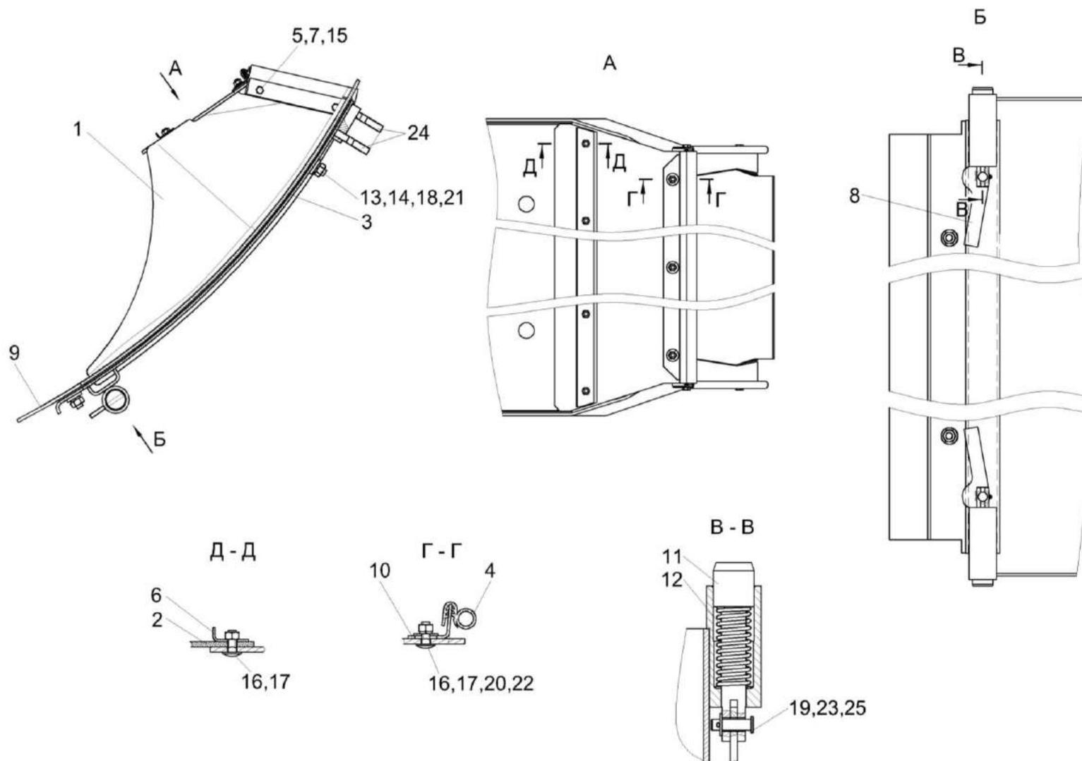
Рисунок 54 – Камера приемная КВК 0141100
