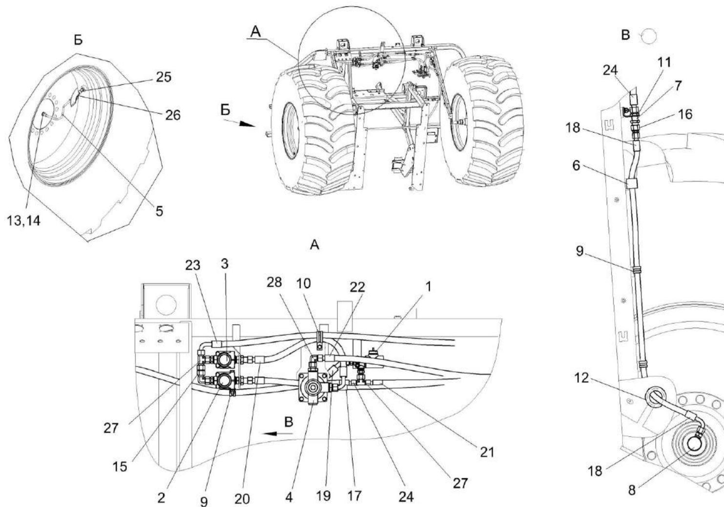
Рисунок 238 – Пневмосистема подкачки шин КВК-6-0801000 (лист 2)
