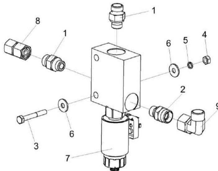
Рисунок 216 – Клапан электроуправляемый КВК-6-0606340
