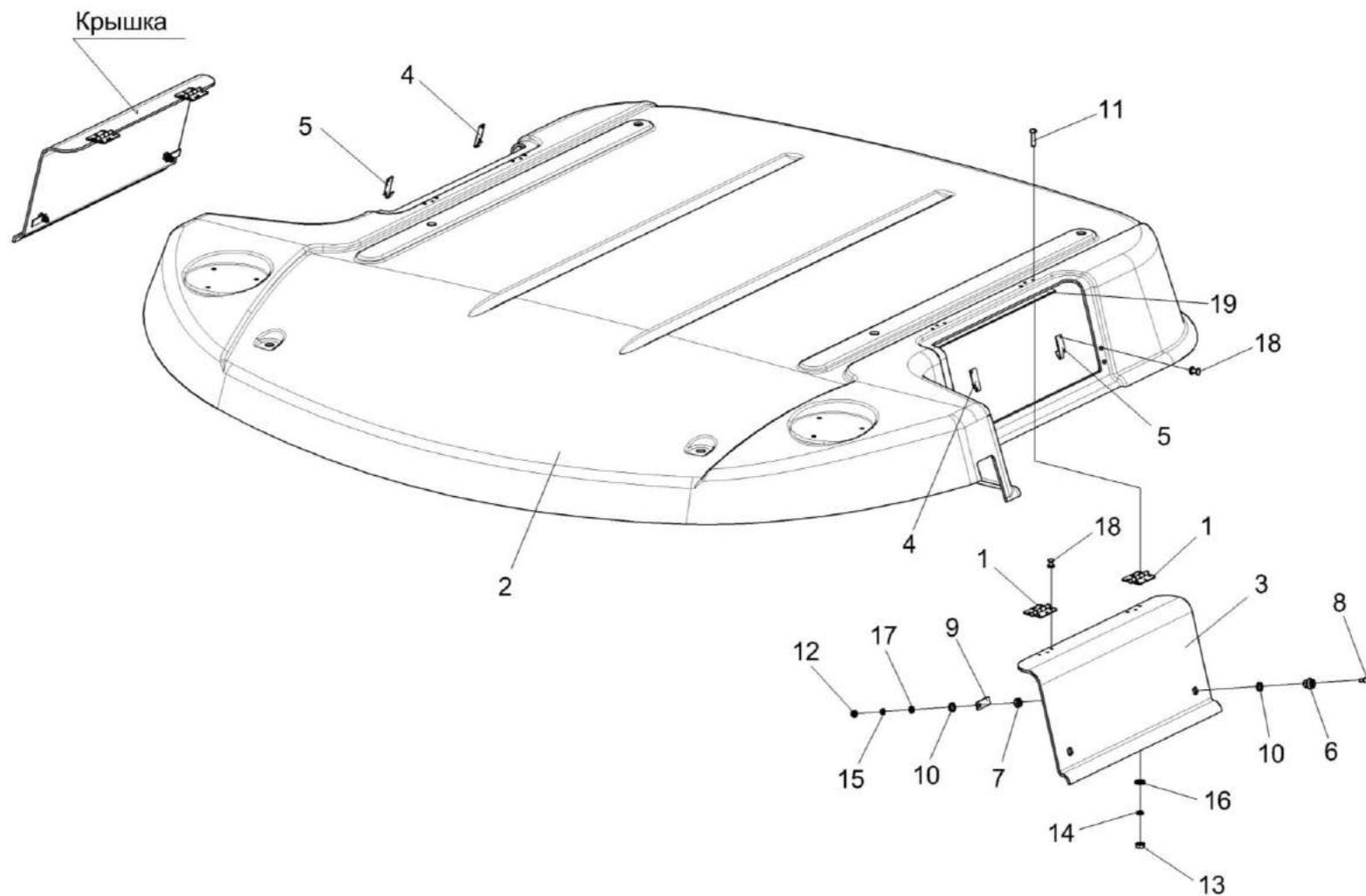
Рисунок 135 – Крыша КВК-6-0120420
