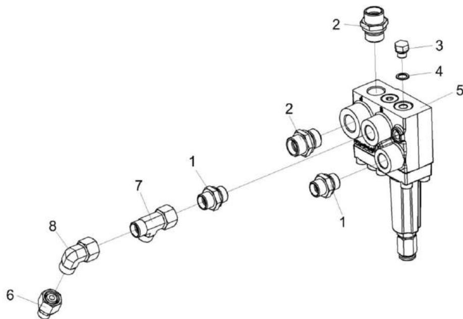
Рисунок 218 – Клапан зарядки пневмогидроаккумулятора КВК-6-0606380
