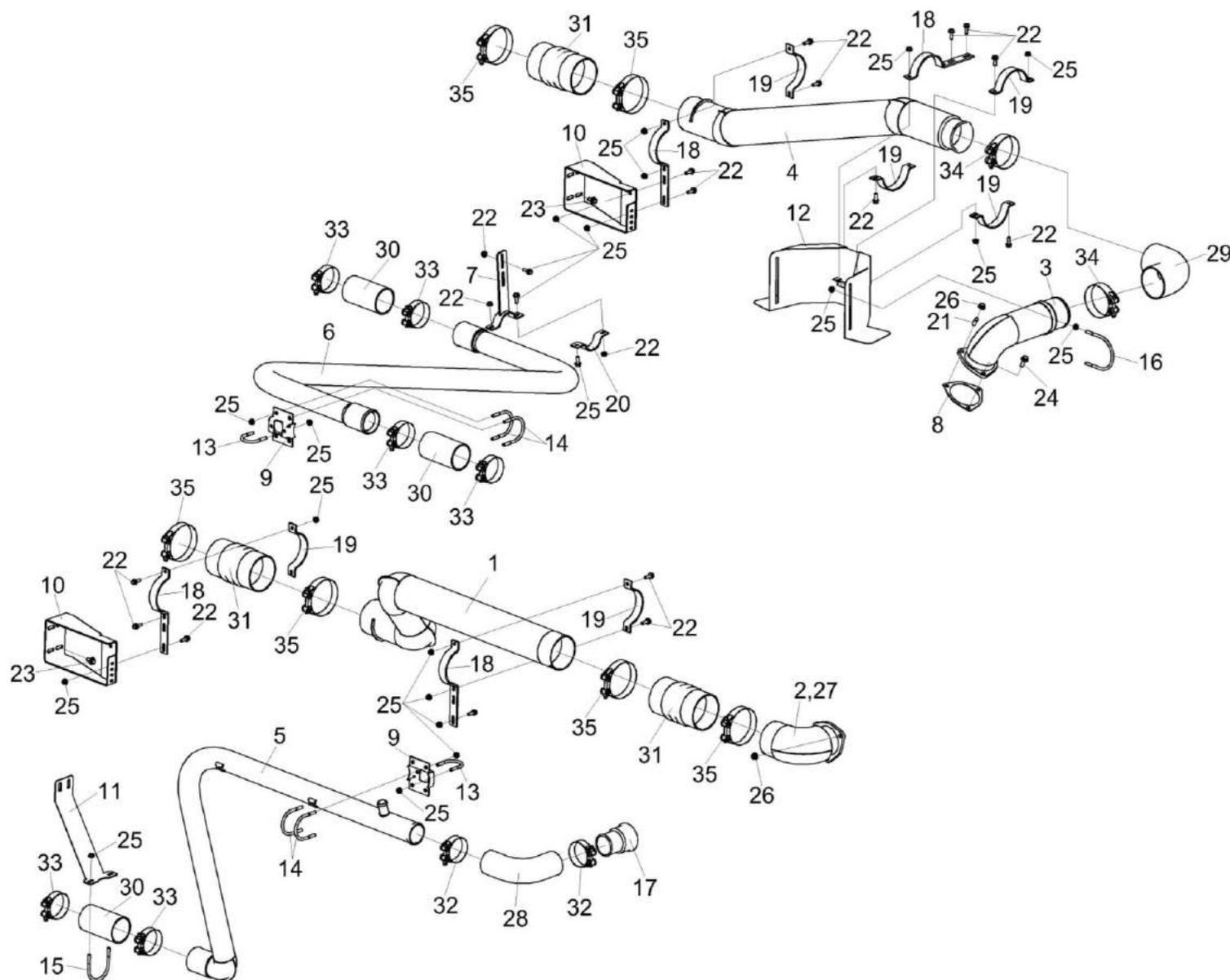
Рисунок 67 – Установка труб КВК-6-0150200
