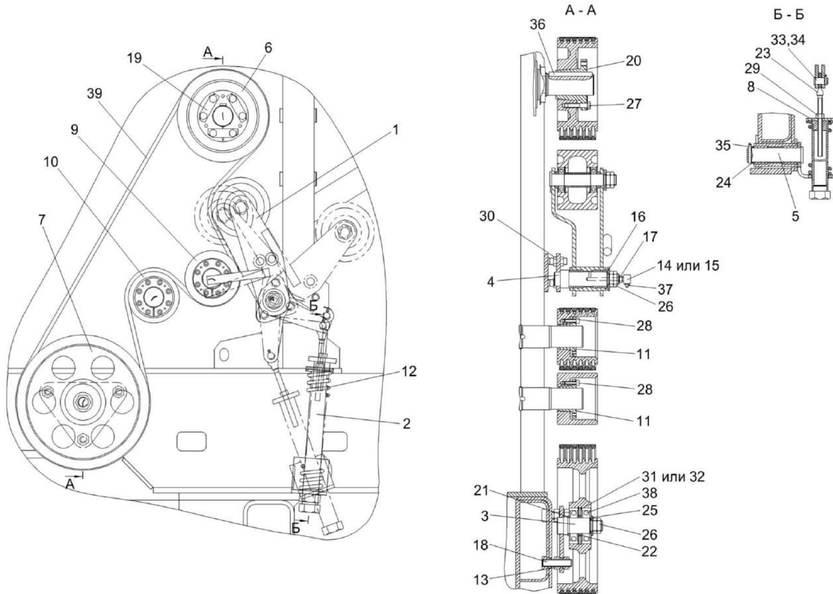
Рисунок 45 – Привод доизмельчающего устройства КВК 0131000
