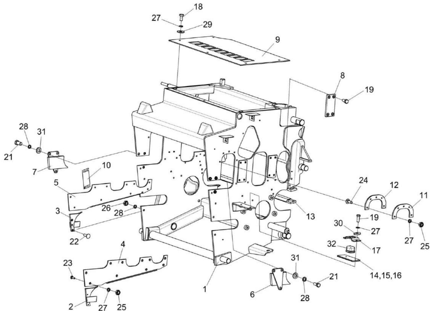
Рисунок 15 – Установка рамы аппарата питающего
