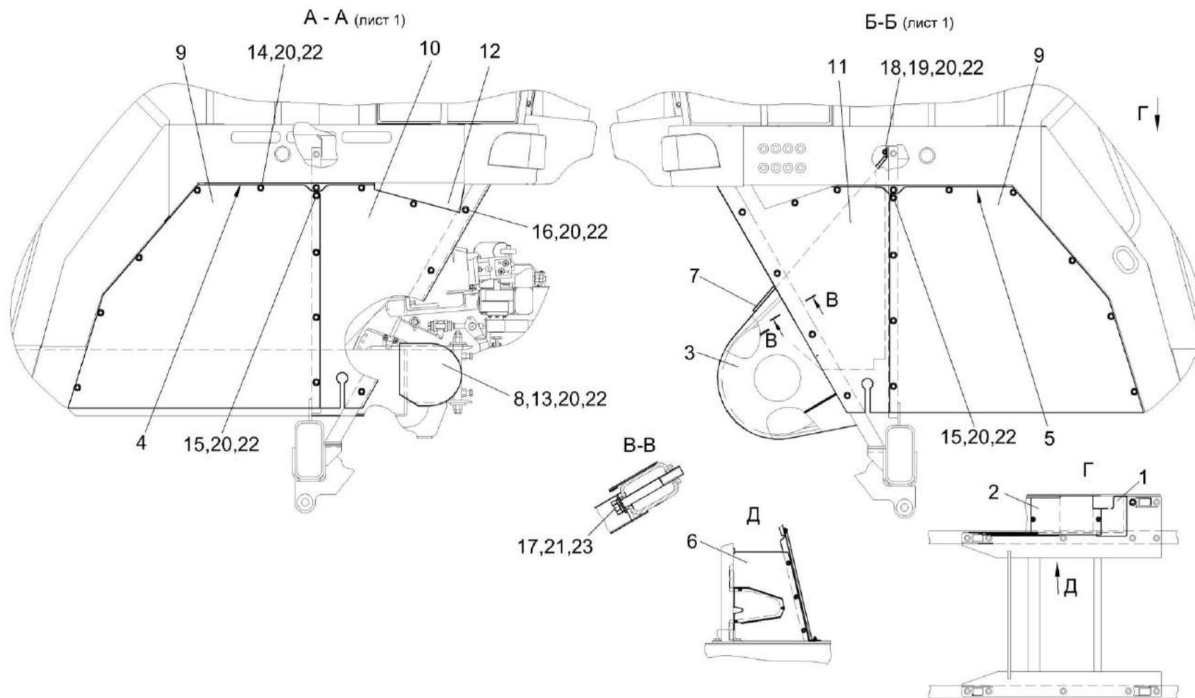
Рисунок 169 – Установка ограждений КВК-6-0100290 (лист 2)
