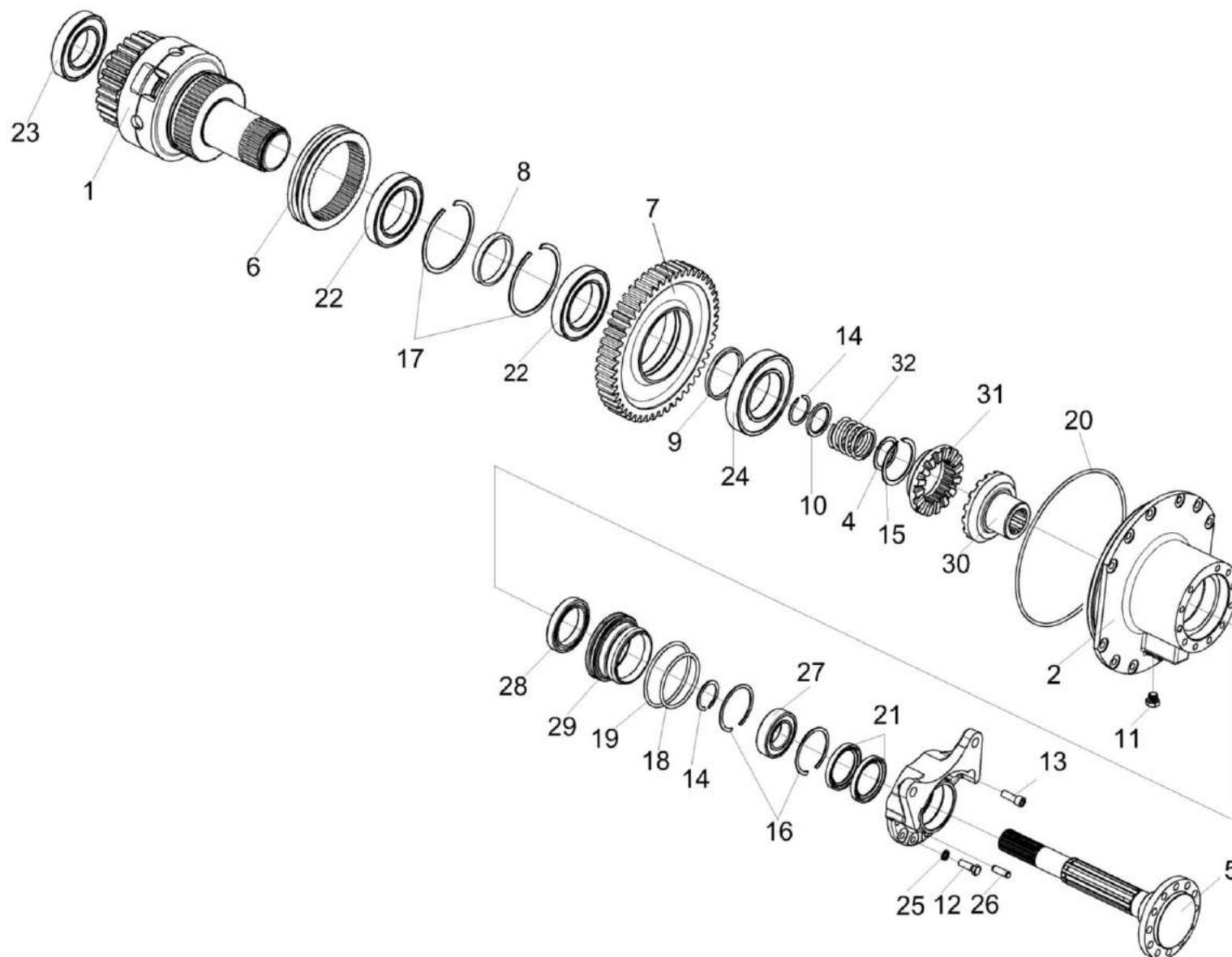
Рисунок 111 – Блок дифференциала КВК-6-0107080
