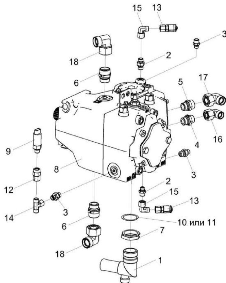
Рисунок 225 – Гидронасос привода питающего аппарата КВК-6-0604120
