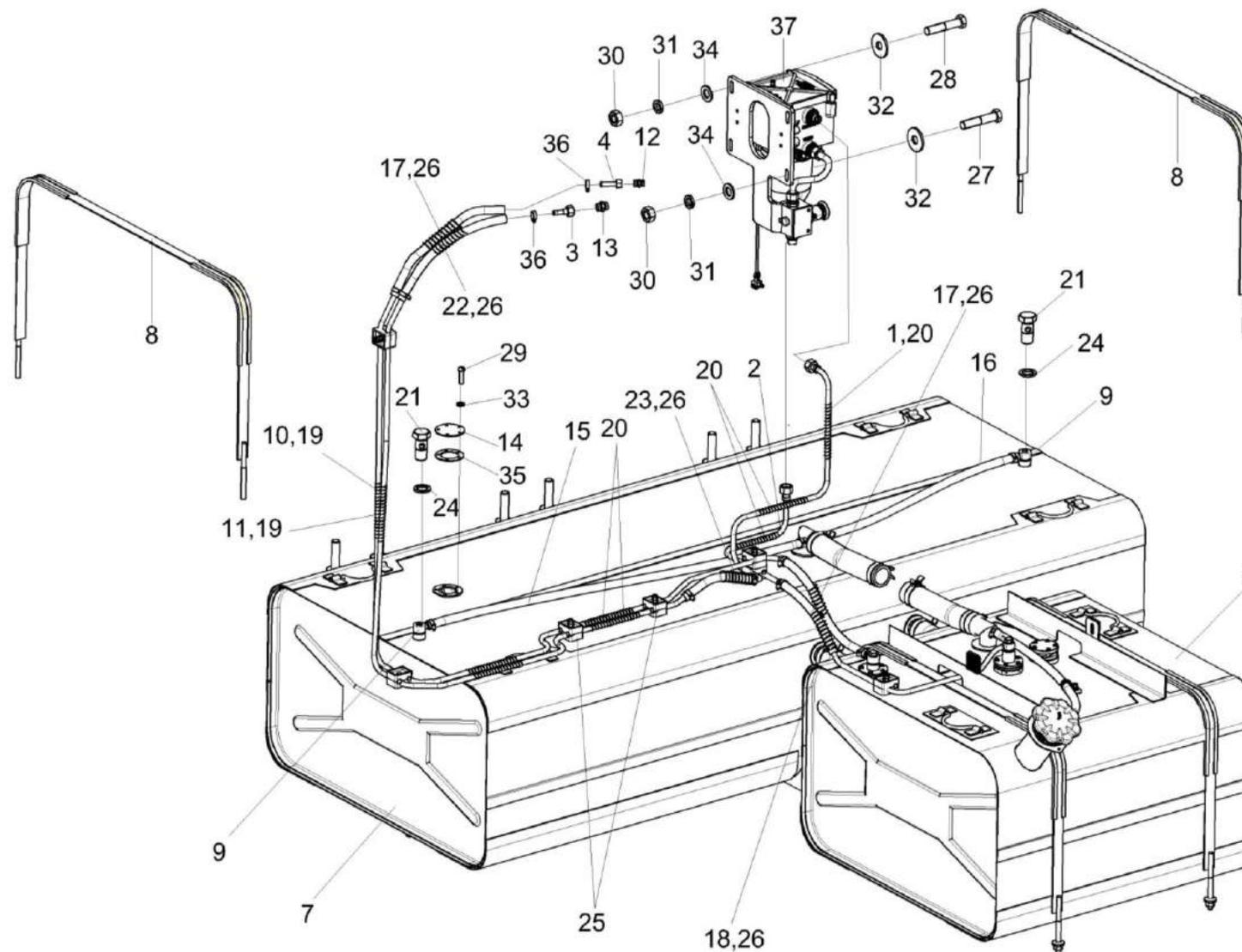
Рисунок 102 – Установка топливного оборудования КВК-6-0103000 (лист 1)
