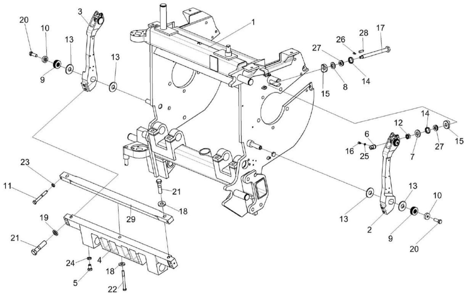
Рисунок 31 – Установка рычагов КВК 0115170 и КВК 0115170-01
