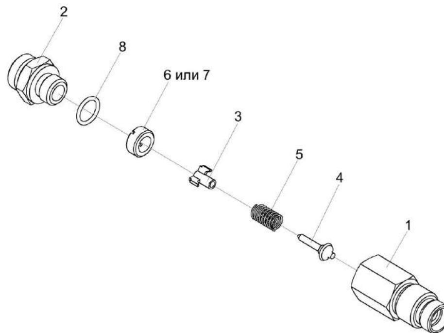
Рисунок 183 – Клапан дренажный КЗК-2-12-0601300
