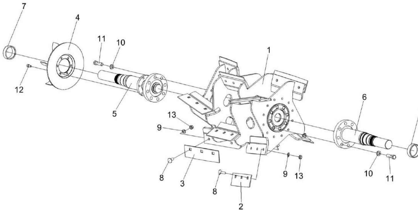
Рисунок 58 – Вал ускорителя выброса КВК 0142410
