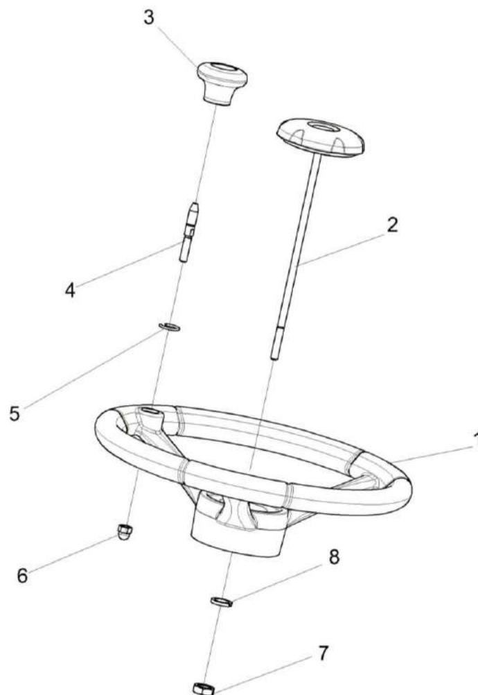
Рисунок 152 – Установка колеса рулевого КЗК-12-0122600-02
