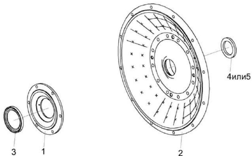
Рисунок 77 – Крышки КВК 0137120 и КВК 0137140
