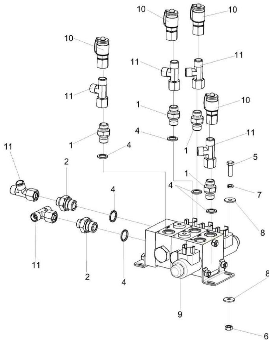
Рисунок 179 – Гидроблок управления переключением передач КВК-6-0601330
