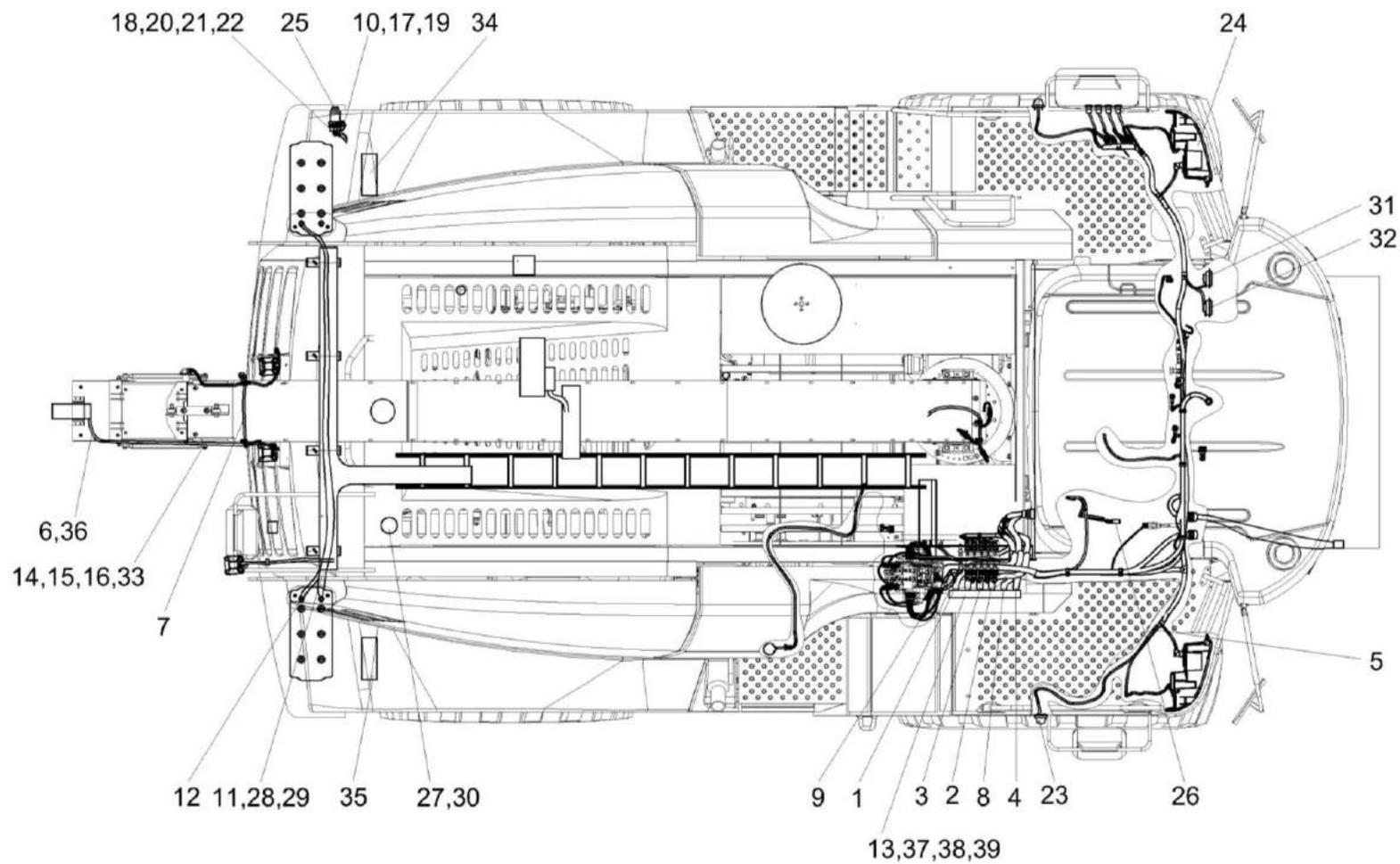
Рисунок 243 – Электрооборудование измельчителя самоходного КВК-6-0721000 (лист 2)
