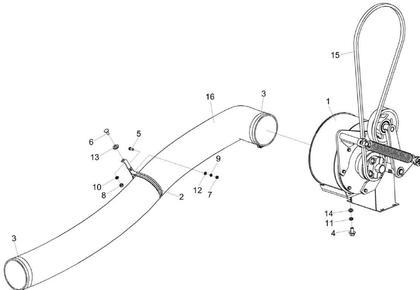
Рисунок 96 – Установка вентилятора отсоса пыли КВК-6-0155700
