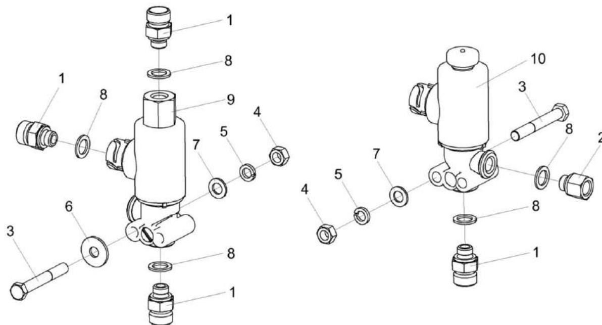
Рисунок 233 – Клапаны электромагнитные КВК-6-0800190 и КВК-6-0800200
