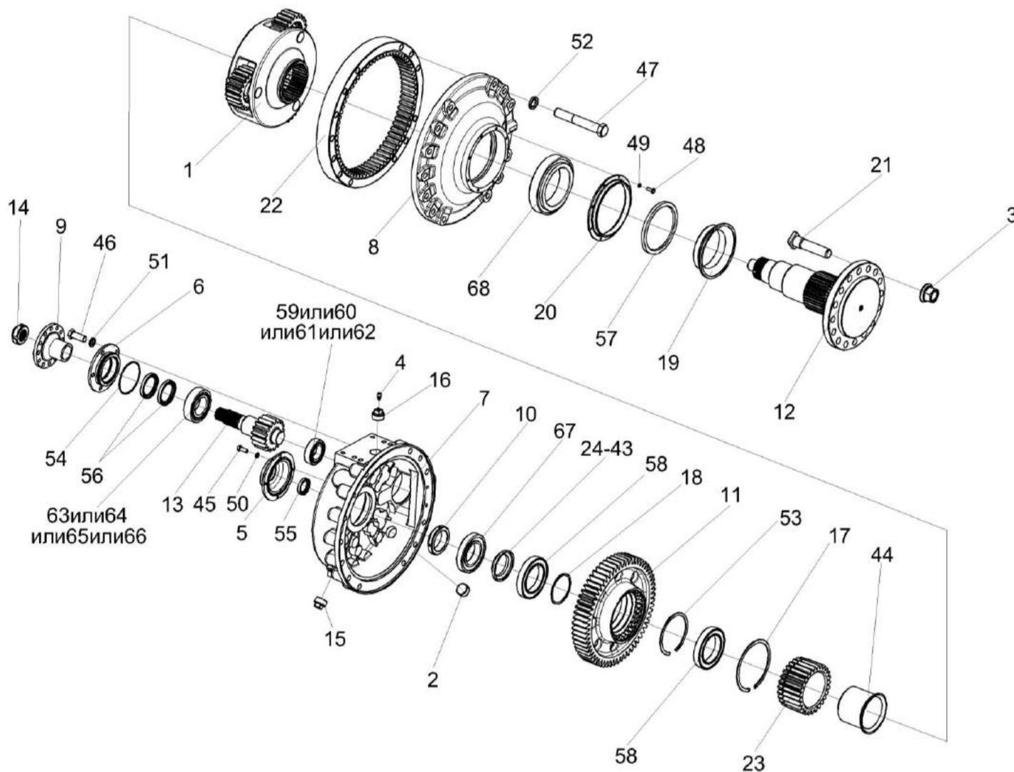
Рисунок 114 – Редуктор бортовой КВК 0106020 (изображено)
