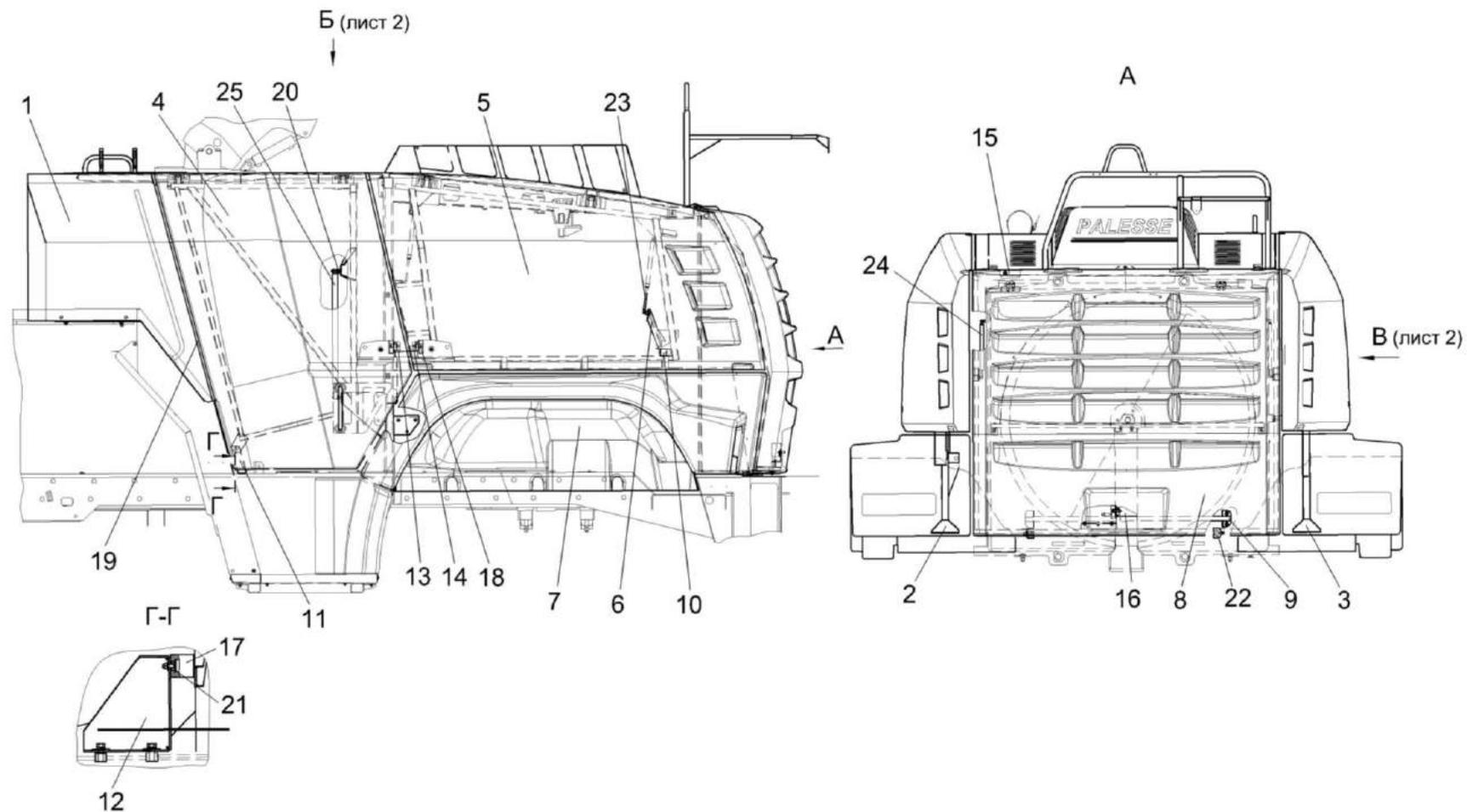
Рисунок 156 – Установка капотов КВК-6-0160000 (лист 1)
