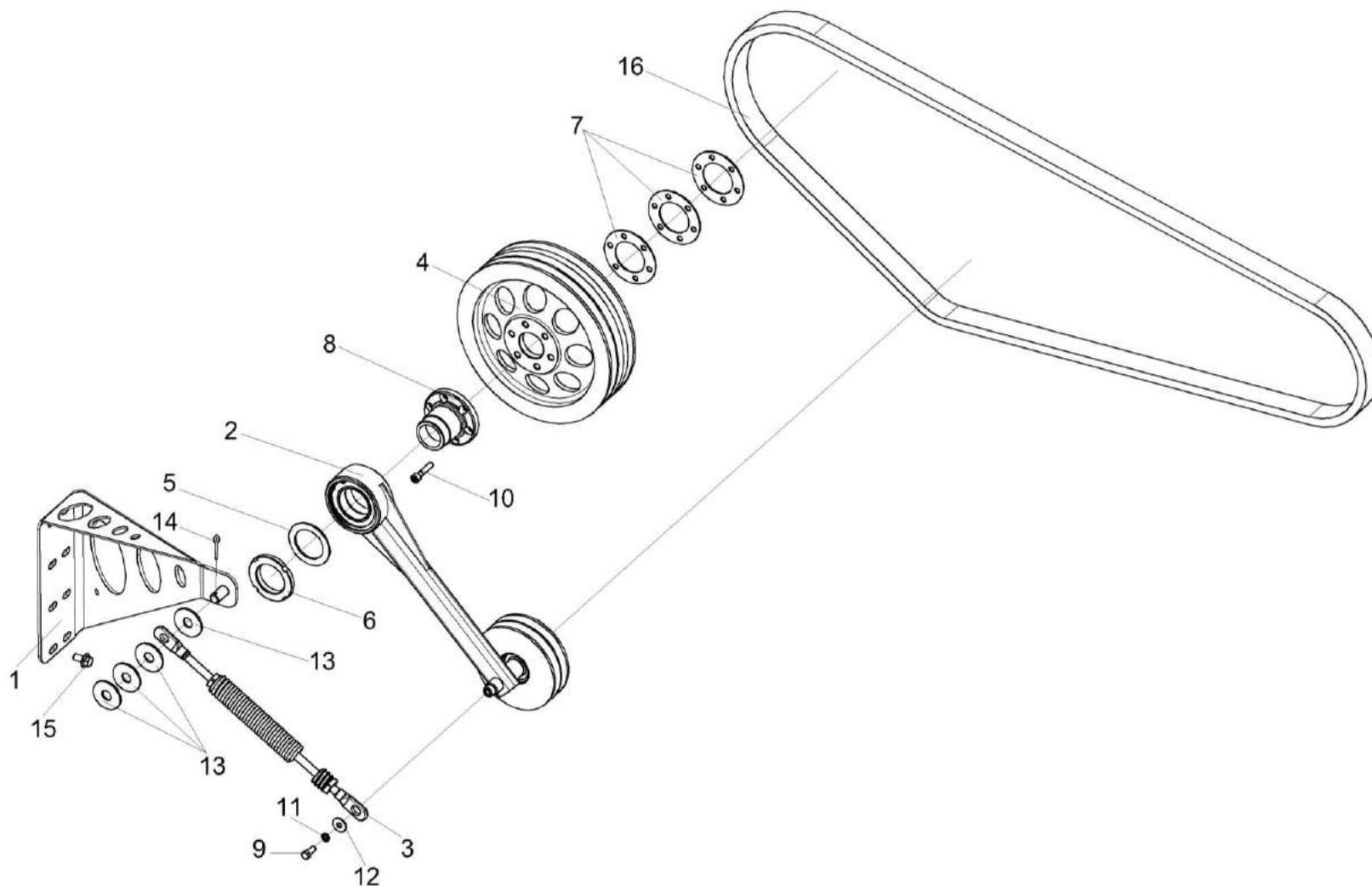
Рисунок 68 – Установка привода вентилятора КВК-6-0150400
