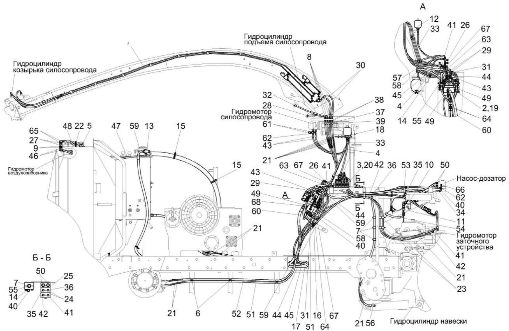
Рисунок 185 – Гидросистема рулевого управления и силовых гидроцилиндров КВК-6-0602000 (лист 2)
