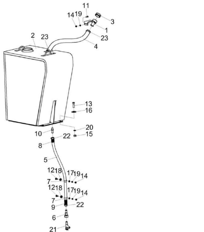
Рисунок 95 – Установка бака AdBlue КВК-6-0158000
