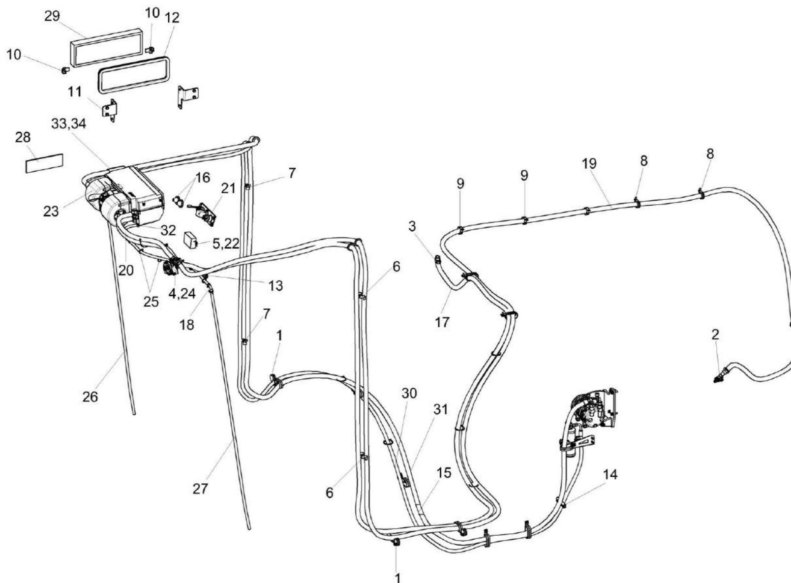
Рисунок 144 – Установка испарителя КВК-6-0121020
