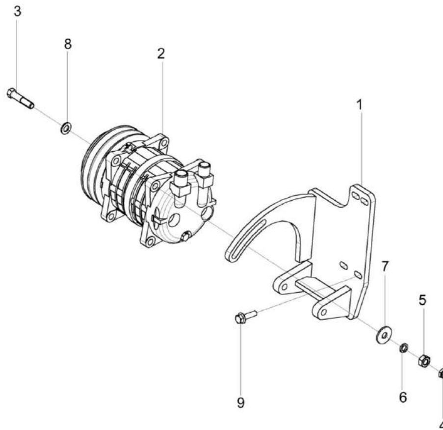
Рисунок 142 – Установка компрессора КВК-6-0121030
