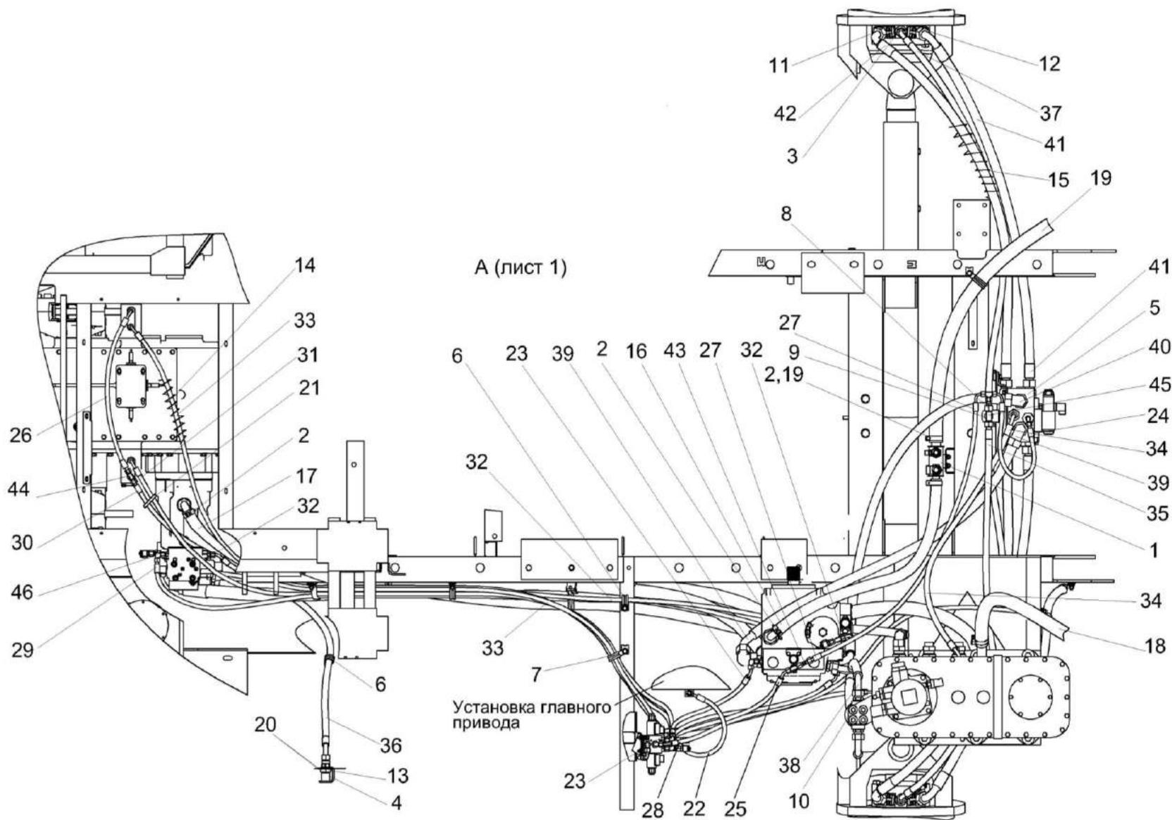
Рисунок 176 – Гидросистема привода ходовой части КВК-6-0601000 (лист 2)
