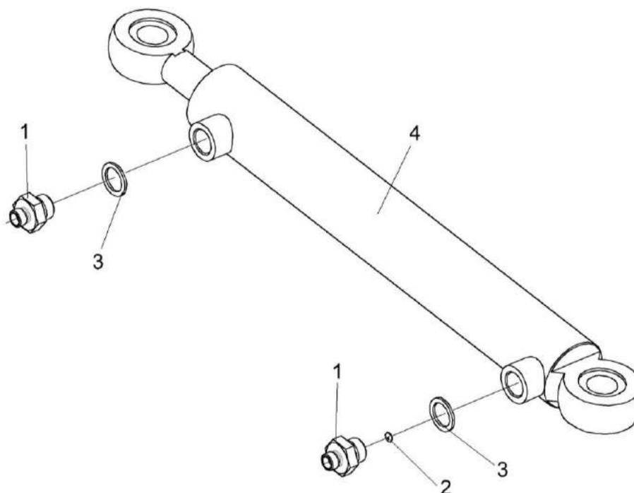
Рисунок 26 – Гидроцилиндр перемещения питающего аппарата КВК 0602520
