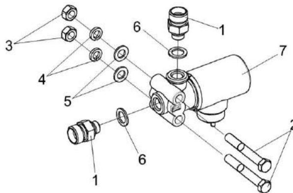
Рисунок 240 – Клапан электромагнитный КВК-6-0801060
