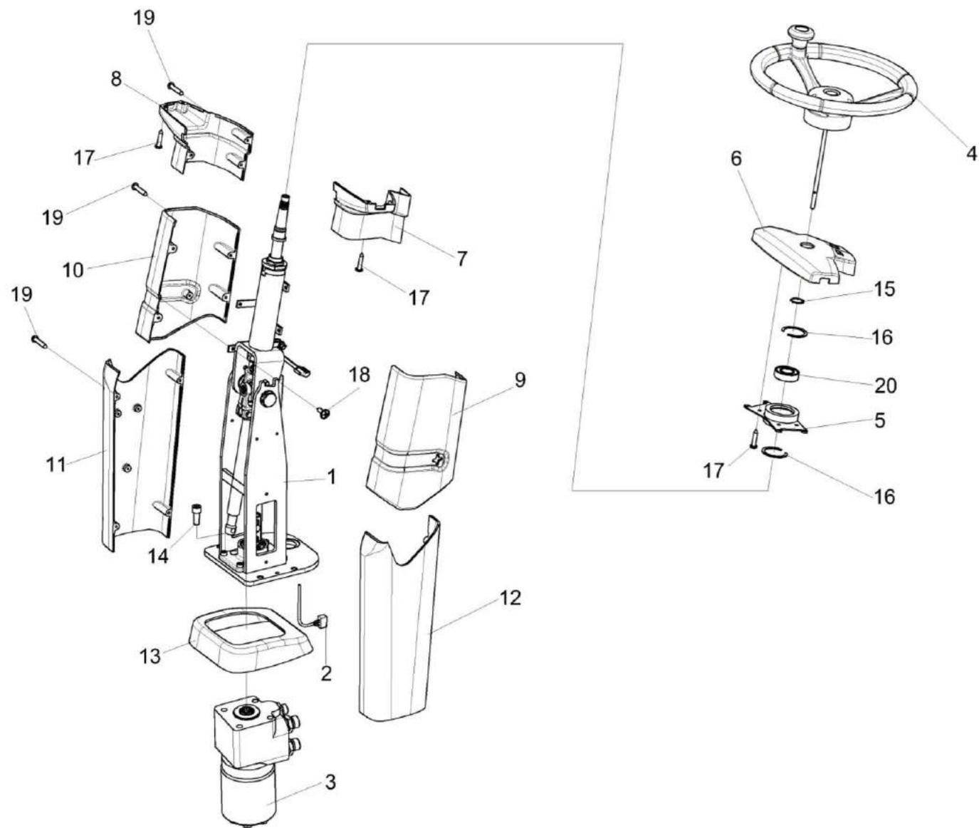
Рисунок 147 – Рулевая колонка КВК-6-0129230
