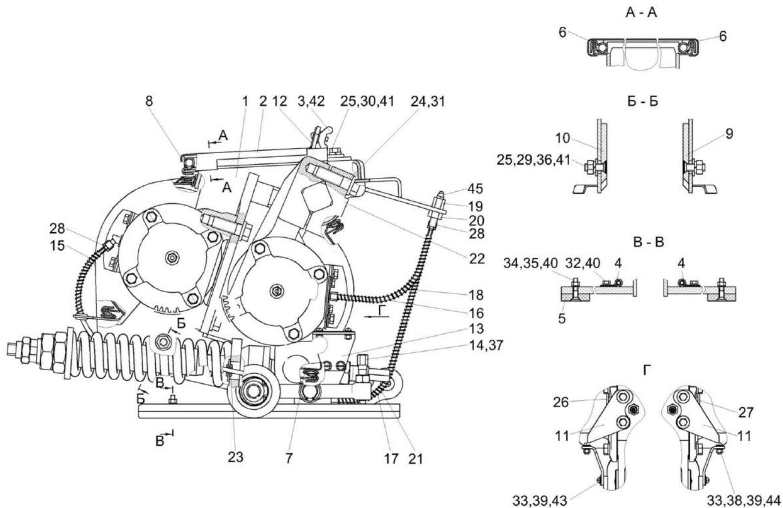
Рисунок 48 – Устройство доизмельчающее КВК 0149010 (лист 2)
