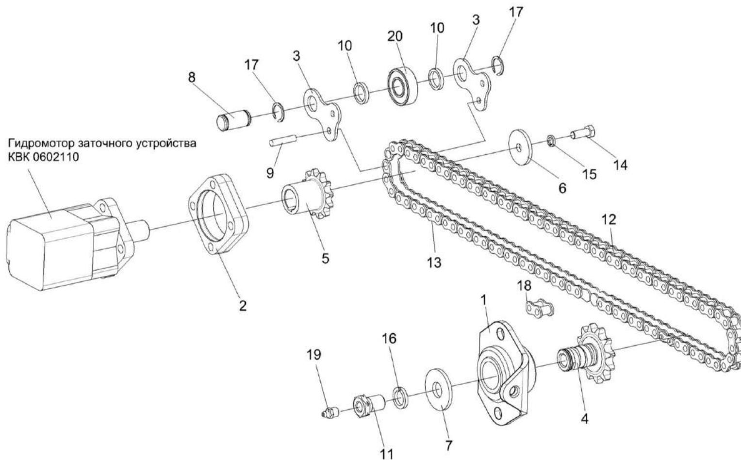
Рисунок 35 – Привод каретки КВК 0116010
