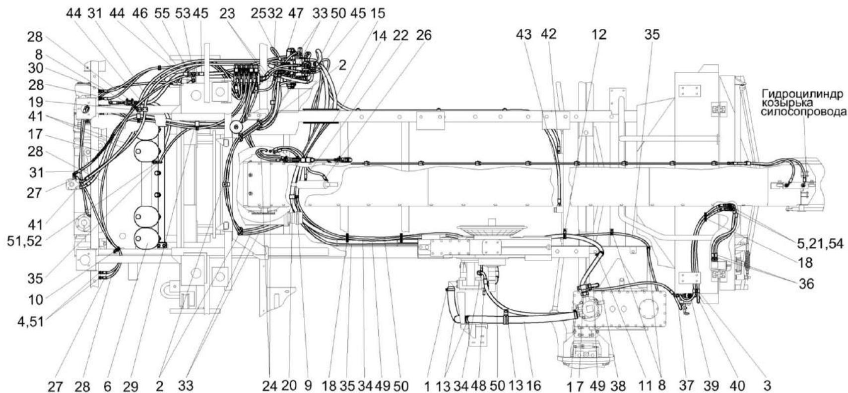
Рисунок 187 – Гидросистема рулевого управления и силовых гидроцилиндров КВК-6-0602000 (лист 4)
