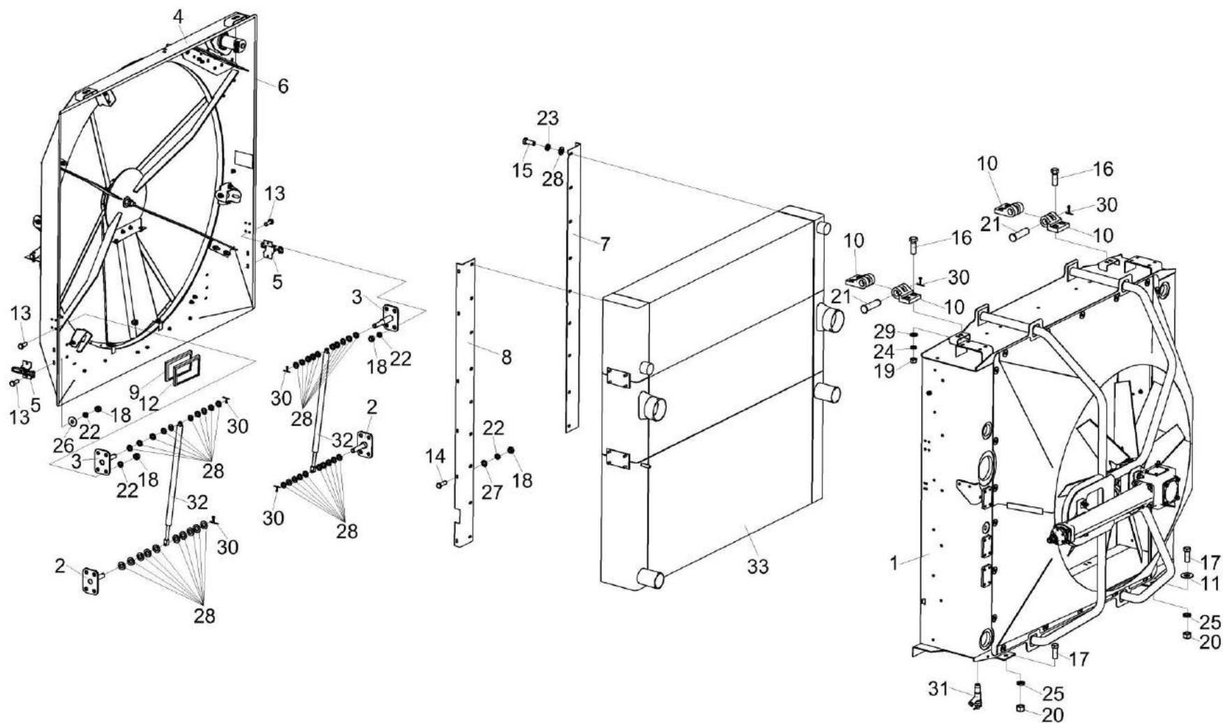
Рисунок 83 – Установка блока радиаторов КВК-6-0152000
