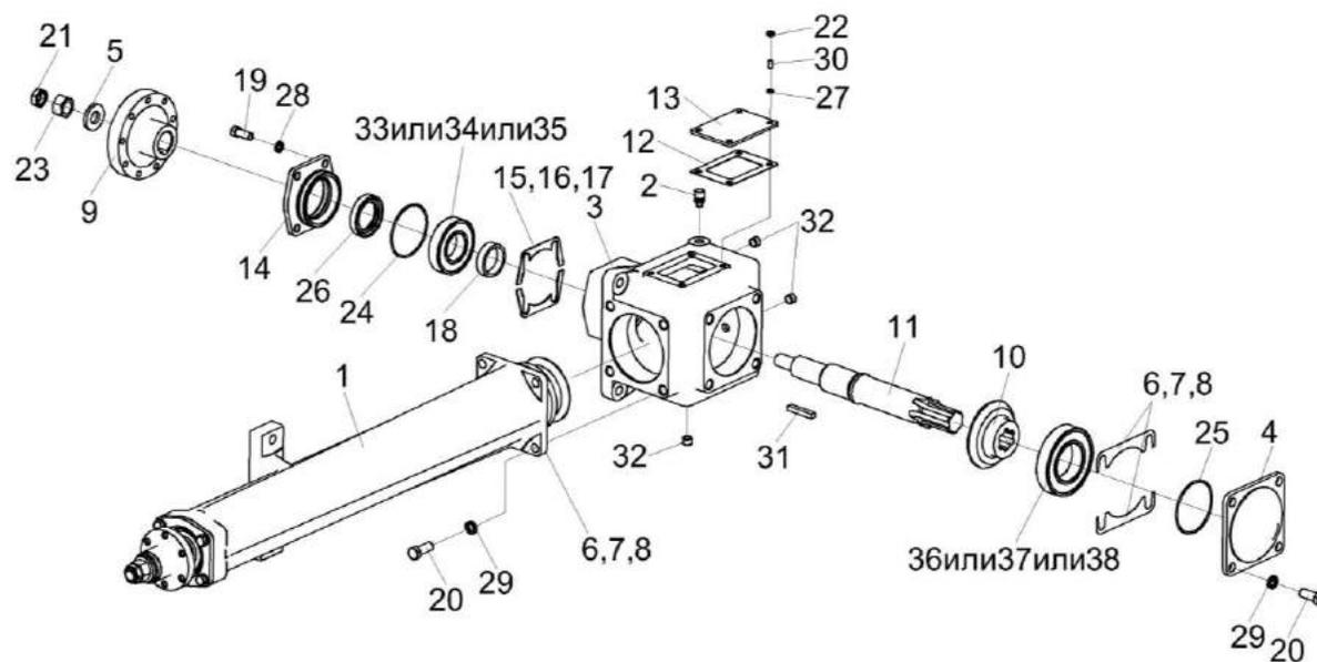
Рисунок 85 – Редуктор КВК-6-0135000
