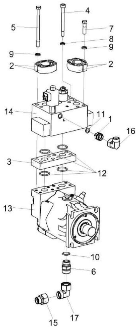
Рисунок 213 – Гидромотор привода питающего аппарата КВК-6-0604200
