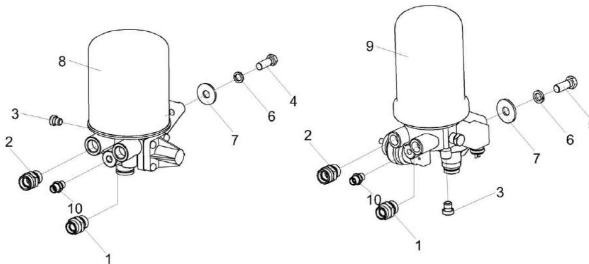
Рисунок 232 – Регулятор давления с осушителем КВК-6-0800160 и с адсорбером КВК-6-0800170
