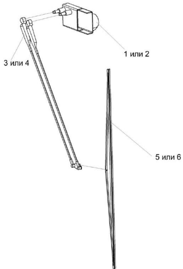
Рисунок 139 – Установка стеклоочистителя КЗК-12-0120810 или КЗК-12-0120810-01
