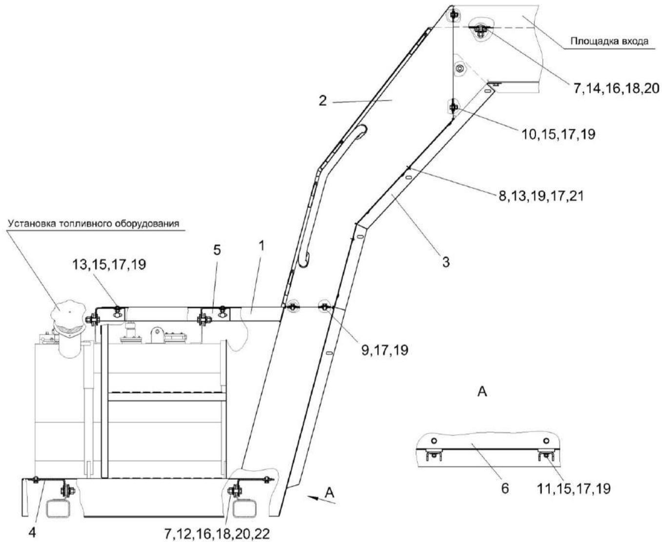
Рисунок 172 – Установка инструментального ящика и ограждений КВК-6-0172000
