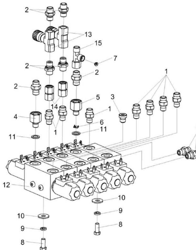
Рисунок 192 – Гидроблок пятисекционный КВК-6-0602310
