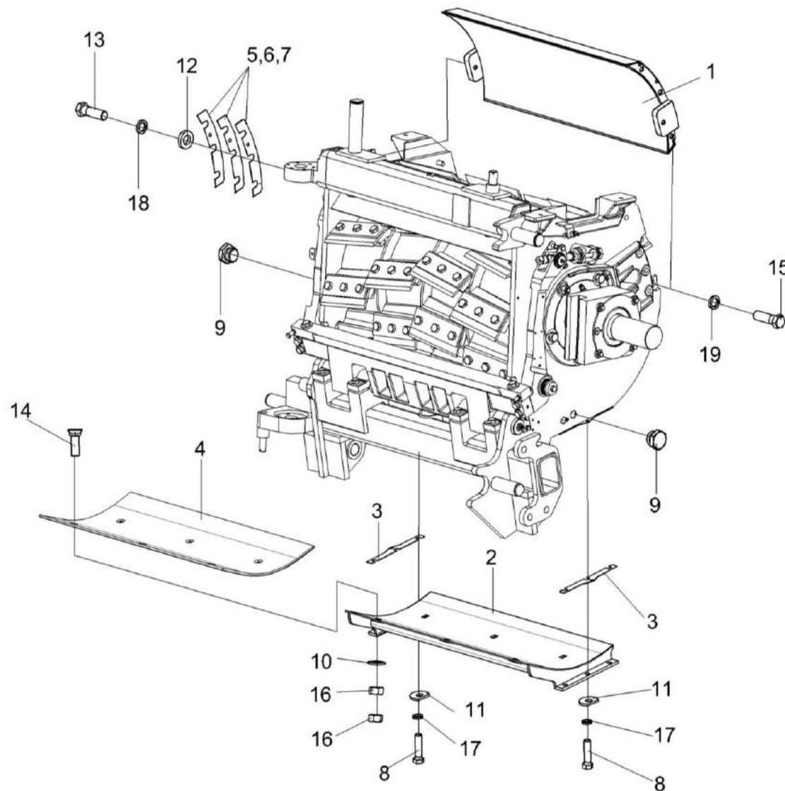
Рисунок 28 – Установка поддона КВК 0115230
